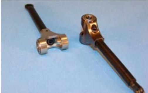
Das Mitnehmer-Gestänge (die alte Version jeweils links in den Bildern) am Rotorkopf wird nun durch eine Querschraube gehalten. Somit ist ein Tausch ohne Demontage vom Blattgriff möglich
