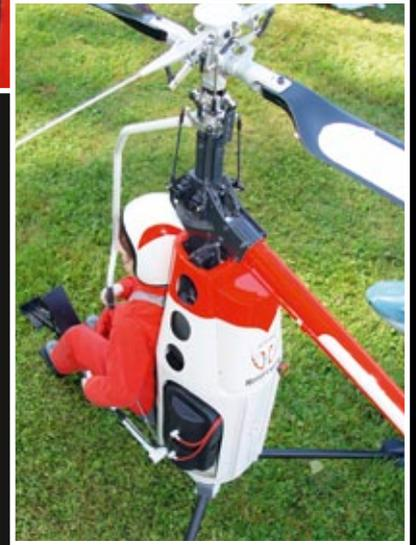
Das Zweiblatt-Hauptrotorsystem LSZ von Bruno Ziegler (Rotordurchmesser etwa 1.500 Millimeter) war seinerzeit serienmäßig mit Steuerpaddeln ausgerüstet. Unterhalb des Taumelscheiben-Außenrings ist der fest verbundene und zum Piloten führende Steuerknüppel zu erkennen, der sich bei allen Steuer-Inputs der vier Taumelscheiben-Servos mitbewegt
