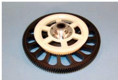
Für den Heckabtrieb wird das vorhandene Riemenrad weiterverwendet
