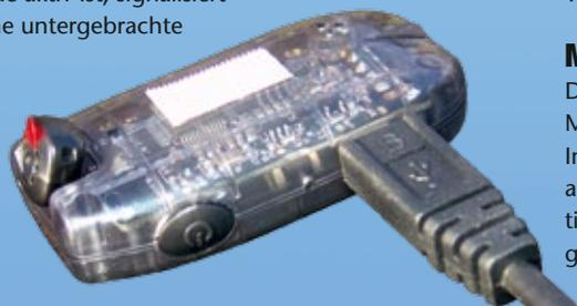
Mittels USB-Verbindung lassen sich die Daten auf den Computer herunterladen, die auf der mitgelieferten micro-SD-Card (2 Gigabyte) gespeichert werden. Neben dem USB-Anschluss befindet sich der Ein-aus-Schalter
