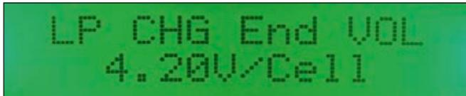
Die maximale Zellen-Spannung ist für jeden Akkutyp einstellbar. Hier ein LiPo-Akku, also 4,2 V/Zelle
