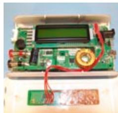
Die vier Touch-Pads in der Frontblende sind per Kabelbaum mit der Hauptplatine verbunden
