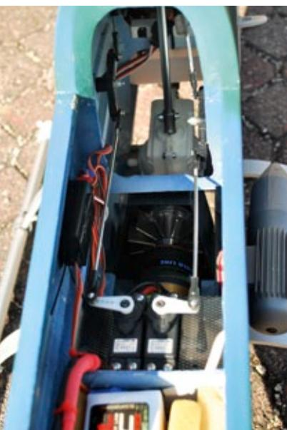
Einbau der Servos und ihre Umlenkhebel zur Taumelscheibe. Der HoTT-Empfänger ist mit Klettband an der linken Rumpfseite befestigt
