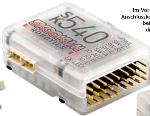
Im Vordergrund die Buchsenleiste mit den Anschlusskontakten. Links an der Gehäuseseite befinden sich die beiden Buchsen zum direkten Anschluss von maximal zwei Spektrum-Satelliten
