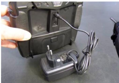
Neben Sender und Empfänger liegt dem Set der Aurora 9X auch noch dieses Netzteil bei. Der Anschluss erfolgt über die obere Buchse auf der Rückseite
