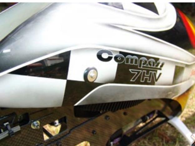
Der neue Hauben-Schnellverschluss lässt sich auf Knopfdruck lösen und wird zusammen mit neuen Stehbolzen für das Chassis geliefert
