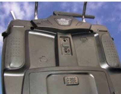
Die Rückseite der Aurora 9X mit ihren gummierten Seitenflanken und Wulsten. In der Mitte zwischen Lade- und Lehrer-Schüler-Buchse befindet sich eine abgedeckte Anschlussmöglichkeit für das HPP-22 PC-Interface
