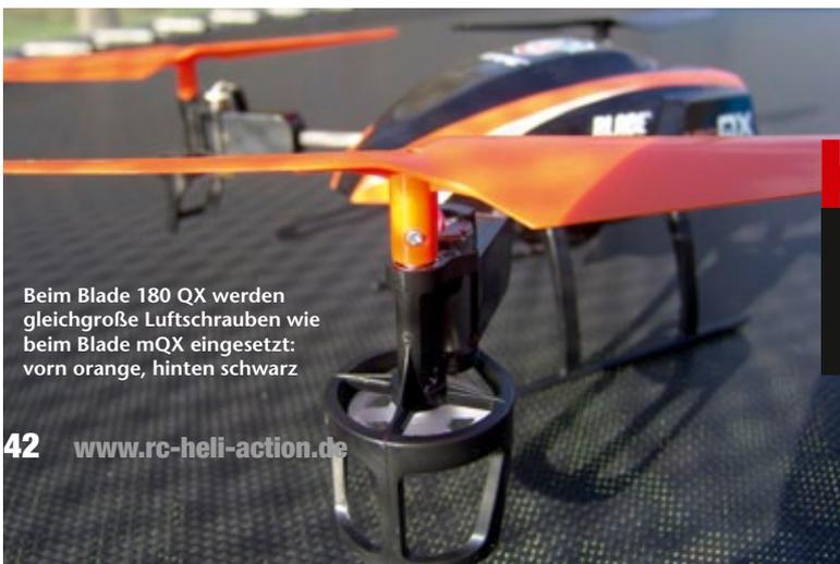
Beim Blade 180 QX werden gleichgroße Luftschrauben wie beim Blade mQX eingesetzt: vorn orange, hinten schwarz
