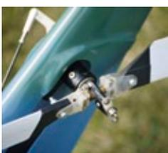
Der Heckrotor wird mit Hilfe eines 2-Millimeter-Drahts, der durch die hohle Heckrotorwelle geführt wird, verstellt. In den Kunststoff-Blatthaltern sitzt jeweils ein Kugellager
