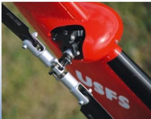
Bei der Turbinen-Cobra kommt ein Ganzmetall-Heckrotor der Firma Benda mit einem doppelten Anlenkhebel zur Spiel-Minimierung zum Einsatz. Die Blatthalter haben jeweils zwei Radial- und ein Axiallager, um die Fliehkräfte aufzunehmen und die Leichtgängigkeit sicherzustellen
