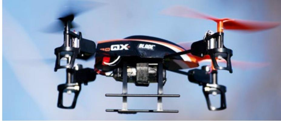
Wer übrigens auf die Montage der Kamera verzichten möchte, kann auch gleich das zusätzliche Kufenlandegestell weglassen. Der Blade 180 QX lässt sich prima auf seinen Motorgondeln landen, ohne dass Schaden entstehen könnte. Man spart dadurch Gewicht und erhöht nochmals enorm die Flugzeit – Minimum 15 Minuten sind so kein Problem.
