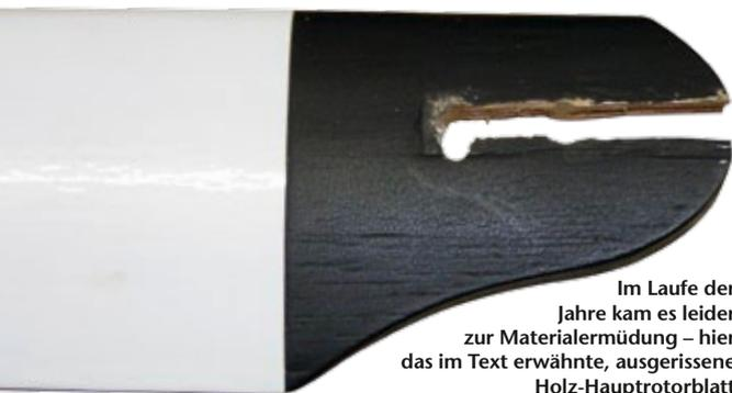
Im Laufe der Jahre kam es leider zur Materialermüdung – hier das im Text erwähnte, ausgerissene Holz-Hauptrotorblatt
