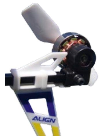
Die Klemmung der Heckmotor-Halterung erfolgt über eine Schraube
