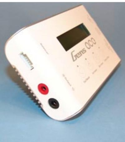
Der erste optische Eindruck ist der eines gut verarbeiteten Geräts mit modernem Design, das wegen seiner runden Kanten und weißen Kunststoff-Front sehr gefällig wirkt. Die Gehäuse-Rückseite aus Aluminiumguss hat integrierte Lüftungsschlitze und kleine Kühlrippen sowie einen praktischen, ausklappbaren Aufsteller.
