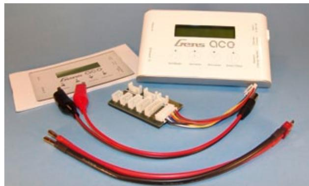
Zum Lieferumfang des GensAce iMars 2 gehört neben den notwendigen Anschlusskabeln und Balancer-Board auch eine Bedienungsanleitung in deutscher Sprache
