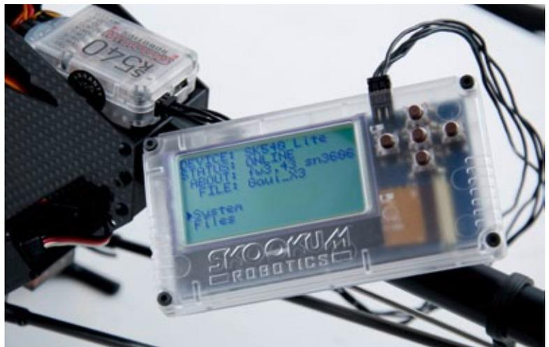
Sehr praktisch beim Flugplatz-Einsatz – der optional erhältliche Field-Programmer. Der Anschluss erfolgt über die Buchse auf der Gehäuserückseite des SK540
