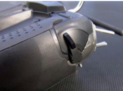
Auf beiden Flanken befinden sich sehr gut erreichbare Slider (Mittelstellung hat Rastung) zum Bedienen von Kanälen oder Sonderfunktionen
