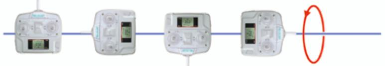
Sender auf horizontaler Fläche mit Bezugsline in die bezeichneten Positionen drehen und markierte Taste drücken. Im Display erscheinen die roten Zahlen.
