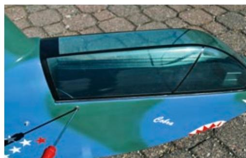
Die Kabinenhaube der Schlüter-Cobra wird beidseitig jeweils mit einer M3-Schraube befestigt. Vorne wird sie von einem Dübel arretiert
