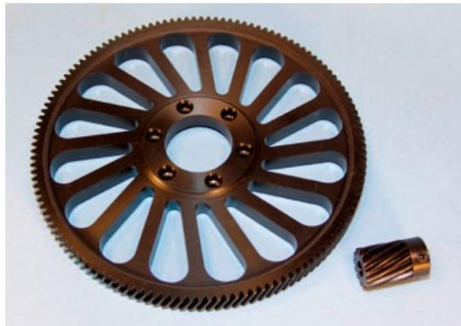
Das neue, schrägverzahnte Hauptzahnrad mit 127 Zähnen ist aus dem Vollen gefräst und läuft deutlich leiser bei gleichzeitig höherer Belastbarkeit
