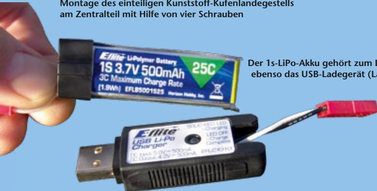
Der 1s-LiPo-Akku gehört zum Lieferumfang, ebenso das USB-Ladegerät (Ladestrom 500 Milliampere)
