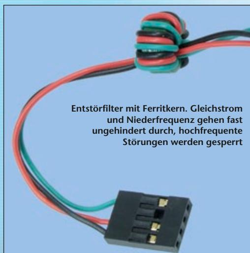
Entstörfilter mit Ferritkern. Gleichstrom und Niederfrequenz gehen fast ungehindert durch, hochfrequente Störungen werden gesperrt
