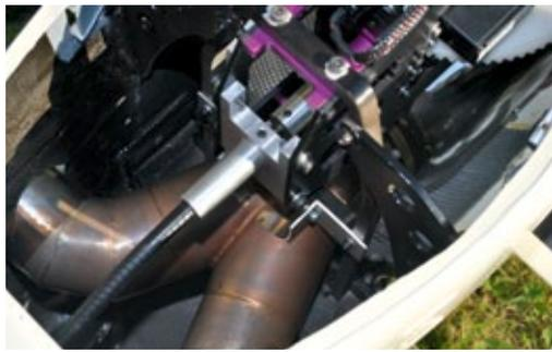
Deutlich zu erkennen sind das im Text erwähnte Abgas-Hosenrohr (V-Abgang) sowie die Flexwelle für den Heckrotorantrieb
