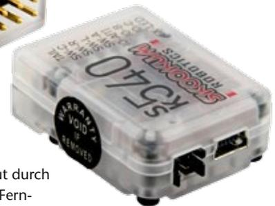
Auf der Rückseite des Clear befinden sich die Anschlussbuchsen für das USB-Kabel sowie das optional erhältliche Display zur Programmierung
