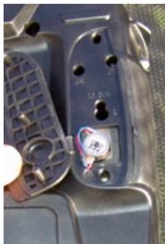
Unter dem linken Gummiwulst ist der Vibrationsmotor verstaut
