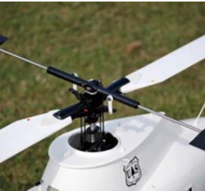
Im Gegensatz zum drehzahlgesteuerten Schlüter-Rotor hier der Hauptrotorkopf von Vario
