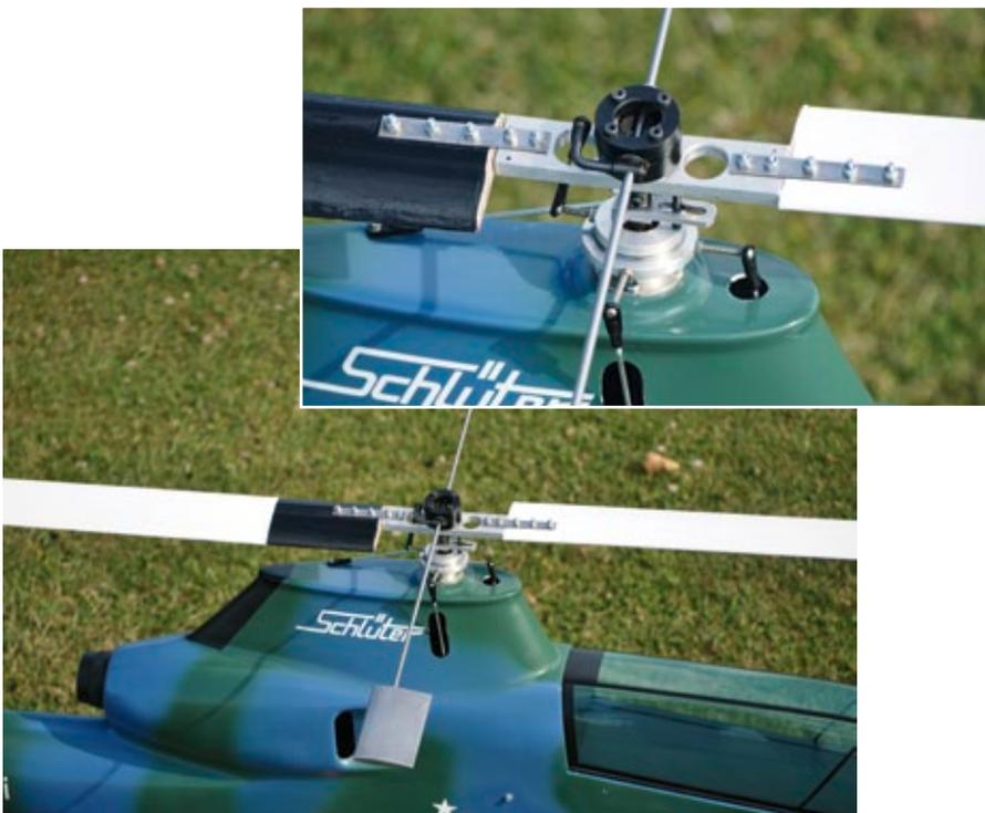
Der fertig montierte Rotorkopf mit den originalen Steuerpaddeln aus Aluminium. Der Anstellwinkel und Blattspurlauf wird durch Verwinden/Verbiegen der Blatthalter-Bleche eingestellt
