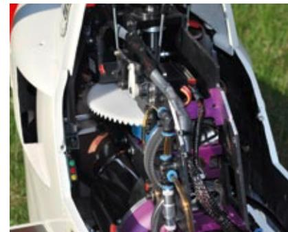
Krasser Kontrast zum einfachen Getriebe der Schlüter-Mechanik ist die JetCat-Turbine in der Vario-Cobra. Ein Stück Technik wie beim bemannten Vorbild – bestehend aus Getriebe, Turbine, Elektronik sowie Schläuchen und Kabel
