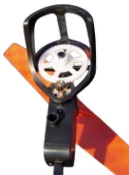
Hat sich bestens bewährt: das einstufige Untersetzungsgetriebe, geschützt von einem ummantelnden Kunststoff-Käfig
