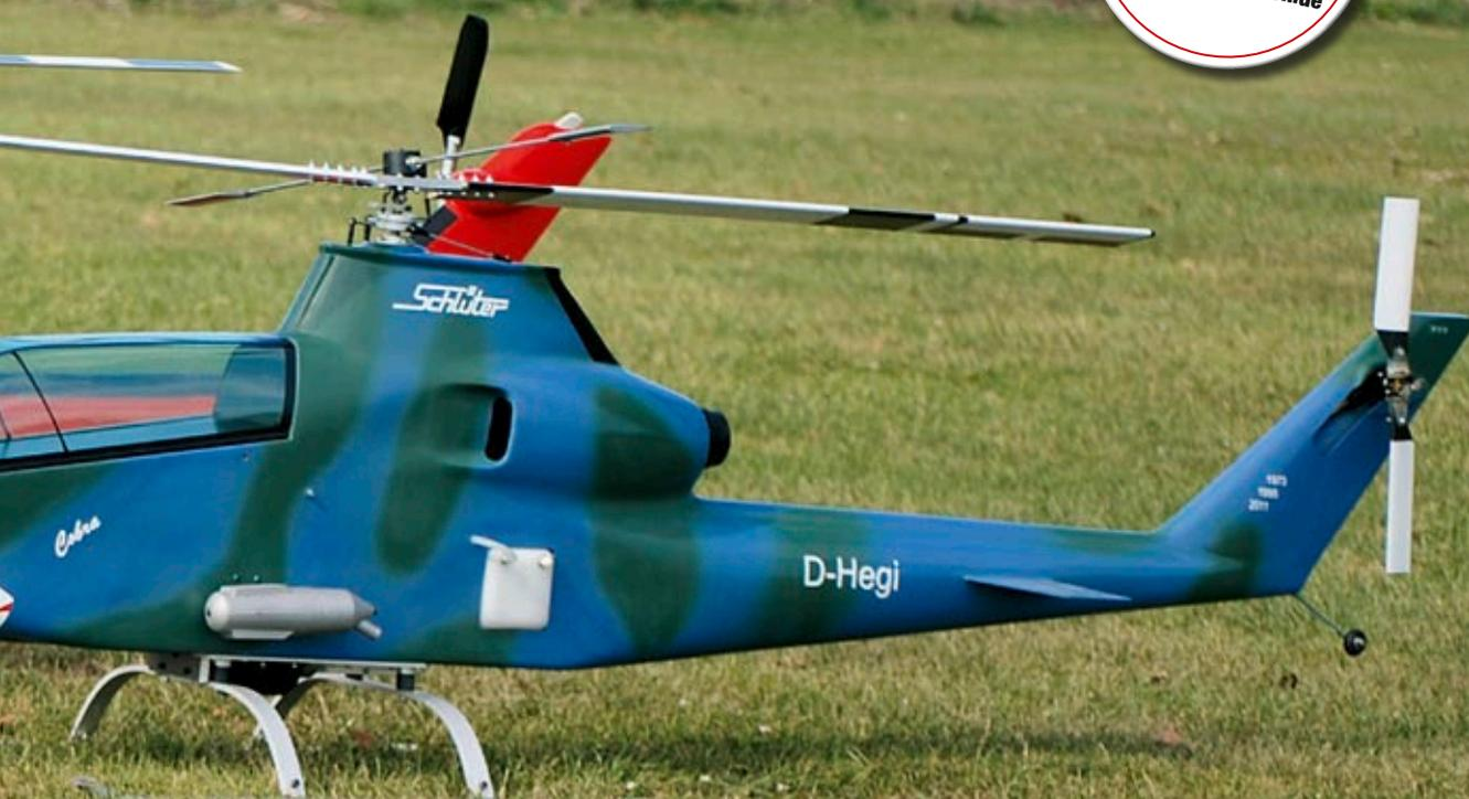
keine Kollektiv-Pitch-Steuerung, sie steigt und fällt ausschließlich durch Drehzahl-Beeinflussung ihres Hauptrotors – ein ganz einfaches Prinzip wie beim Flächenmodell. Gas geben heißt steigen, Gas zurück heißt fallen. Natürlich ändern sich hierbei die Drehmomente, was über den Heckrotor ausgeglichen werden muss.
