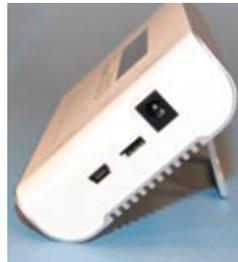
Rechts wird die Stromversorgung steckbar über eine Inline-Buchse hergestellt. Die Eingänge daneben dienen zum Anschluss eines Temperatursensors und USB-Kabels
