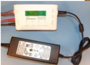
Das GensAce-Netzteil ist auf die Versorgung des iMars 2 leistungsmäßig abgestimmt
