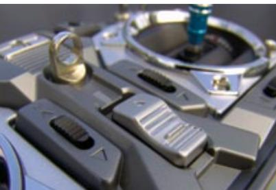
Über dem mittig angeordneten Ein-Aus-Schalter sitzt die Befestigungsöse für den Trageriemen
