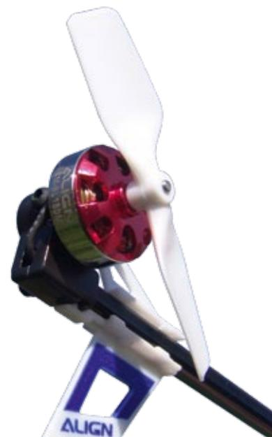
Auch am Heckrotor arbeitet ein kräftiger BL-Außenläufer, der sicher in der Halterung arretiert ist
