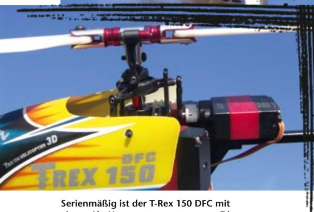
Serienmäßig ist der T-Rex 150 DFC mit einem Alu-Hauptrotor ausgestattet. Die Mitnahme des Taumelscheiben-Innenrings erfolgt über zwei Steuerstangen
