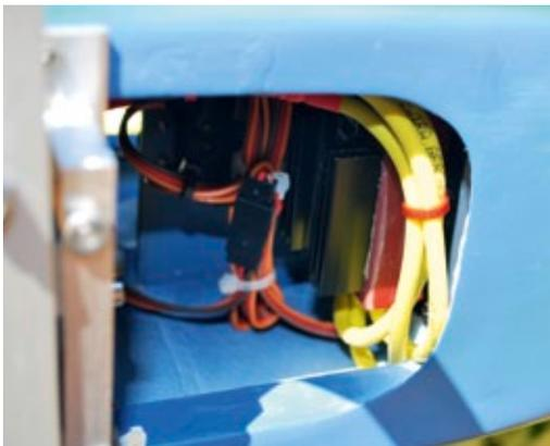
Ansicht von der Rumpf-Unterseite. Der Kontronik-Controller Jive 80 HV ist auf der Unterseite direkt vor dem Motor platziert und kann auch dort Frischluft beziehen
