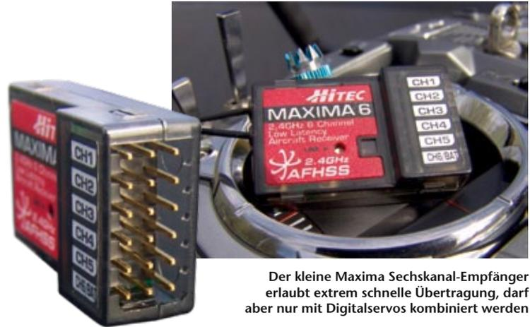
Der kleine Maxima Sechskanal-Empfänger erlaubt extrem schnelle Übertragung, darf aber nur mit Digitalservos kombiniert werden
