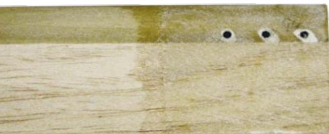
Neue Holzrotorblätter wurden zur Verstärkung im Wurzelbereich mit Glasgewebe und Epoxydharz verstärkt
