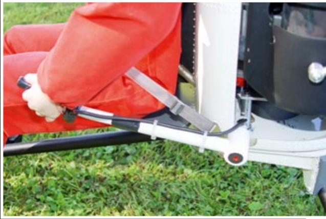
Sogar der Pitchhebel und der zyklische Steuerknüppel wurden beweglich ausgeführt
