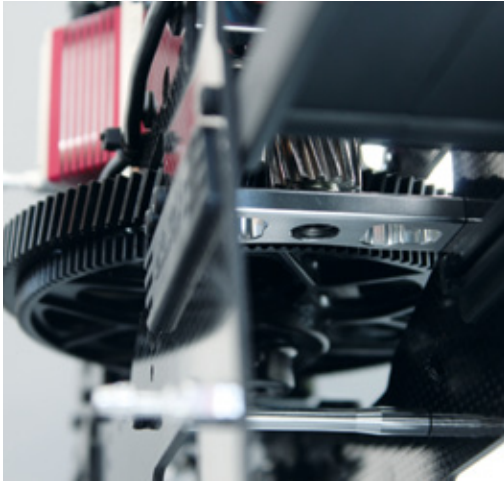
Abgefangen: Die Motorwelle wird hinter dem Ritzel nochmals gelagert
