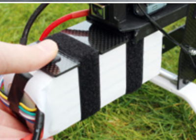
Der auf einer CFK-Platte fixierte 6s-LiPo-Akku wird von vorne ins Chassis eingeschoben
