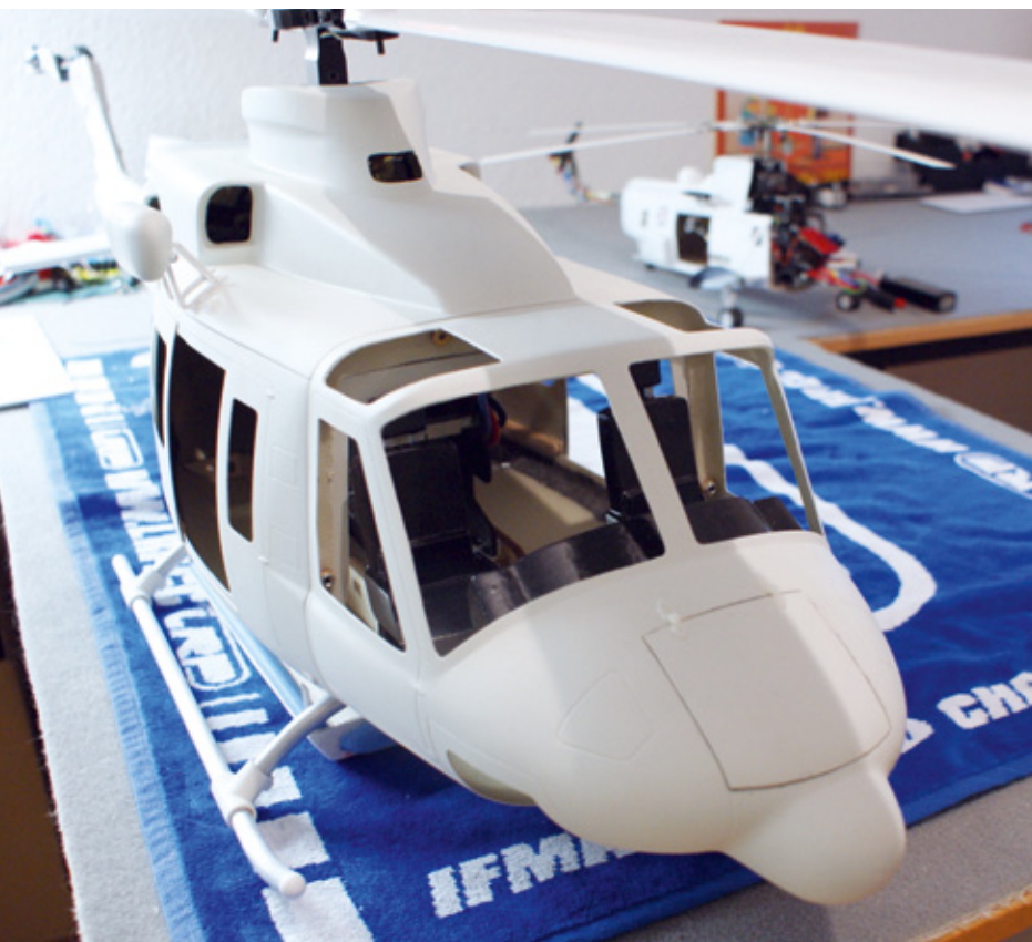
Der weitestgehend rohbaufertige Rumpf wartet auf seine Lackierung
