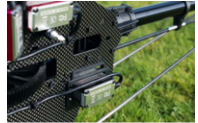
Das Heckservo ist im Chassis verschraubt und direkt mit der CFK-Schubstange verbunden. Für schwingungsfreie Lagerung des Stabs sorgen Führungen
