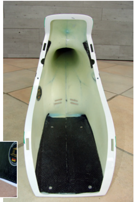
Die Rumpfteile sind gezielt mit Carbon-Fasern (=> höhere Steifigkeit, niedrigeres Gewicht) verstärkt
