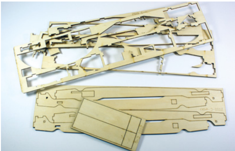
Die zum Rumpfbausatz gehörenden Spanten mussten zur Aufnahme der CopterX-Mechanik geringfügig modifiziert werden
