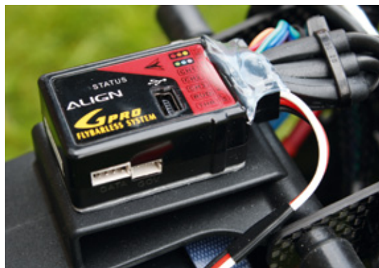
Das mittlerweile schon bestens bewährte Gpro-Flybarless-System. Die Anschlussstecker wurden mit Heißkleber fixiert
