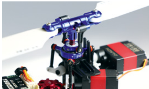
Der DFC-Kopf nebst Tuning-Taumelscheibe. Deutlich zu erkennen sind die hinter den Kugelgelenken sitzenden O-Ringe
