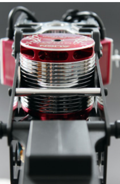
Maßgeschneidert – viel Luft zum Chassis hat der Außenläufer nicht mehr
