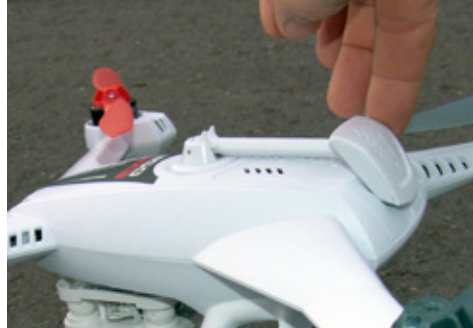
Der ausklappbare GPS-Mast optimiert die GPS-Empfangsbedingungen
