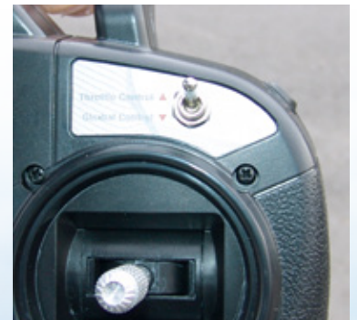
Der rechte Zweizeige-Schalter dient zum Umschalten auf Tilt-Funktion
