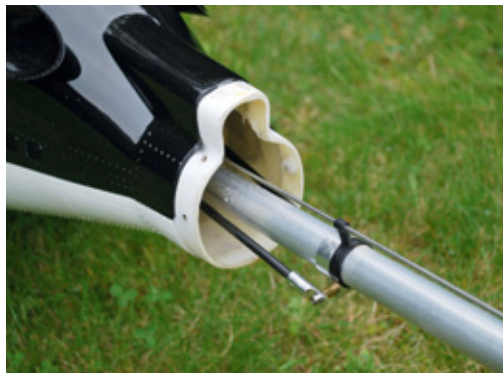
Die im Rumpf eingesetzte Mechanik muss fachgerecht ausgerichtet werden, bevor der Heckausleger aufgesetzt und verschraubt wird
