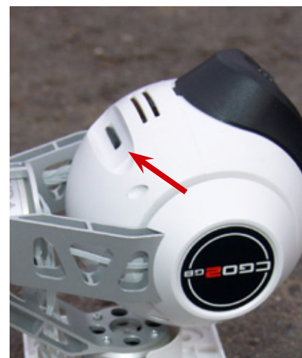
Der Einschub für die Micro-SD-Karte erfolgt an der Rückseite der Kamera
