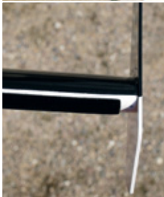
Die Fugen des Höhenleitwerk-Rumpf-Übergangs wurden mit UHU Plus verschlossen und anschließend mit einem weißen, wasserfesten Lackmalstift abgedeckt
