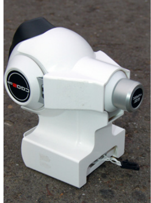
Herzstück des Film-Equipments ist das Blade/Yuneec-Dreifachs-Gimbal mit Full-HD-Kamera CGO2. Die weiße ABS-Abdeckkappe schützt die bewegliche Mechanikeinheit beim Transport
