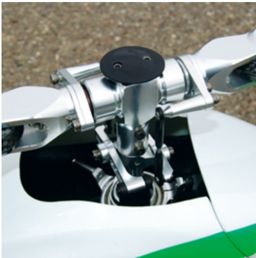
Die Taumelscheibe bleibt aerodynamisch perfekt auf ihrem gesamten Verfahrweg innerhalb der Rumpfkontur
