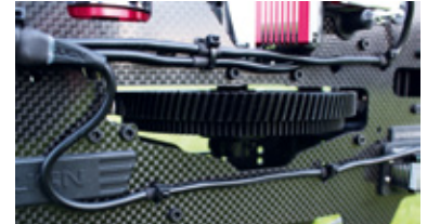
Saubere Sache – fachgerecht am Chassis verlegte und fixierte Anschlusskabel
