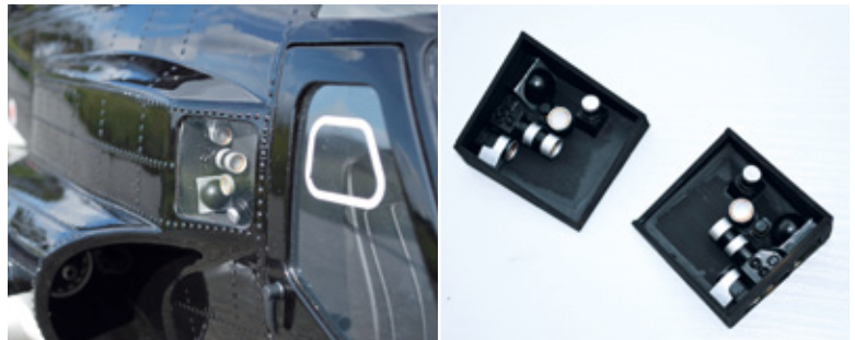
Die Seitenkameras werden in einen vorgegebenen Rahmen im Rumpf eingeklebt – eingebaut sieht es sehr gut aus
