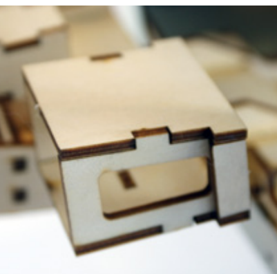
Durch entsprechende Verzapfungen an den Spanten wird das Holzgerüst sehr stabil
