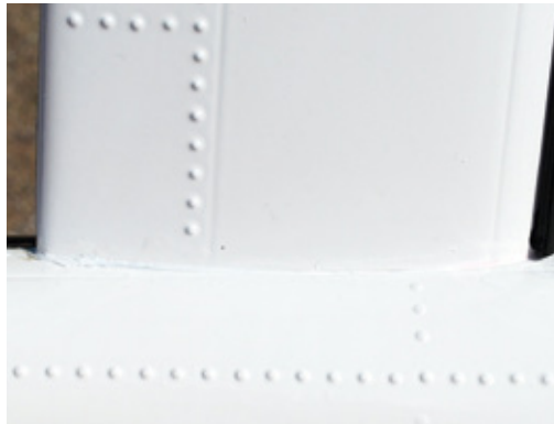
Die Fugen des Höhenleitwerk-Rumpf-Übergangs wurden mit UHU Plus verschlossen und anschließend mit einem weißen, wasserfesten Lackmalstift abgedeckt
