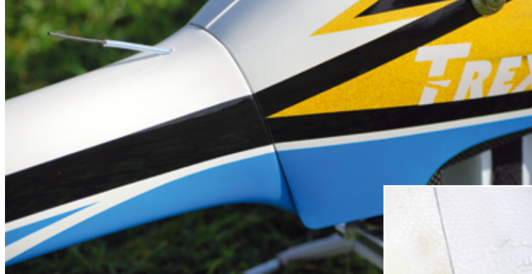
Spaltfreier Übergang: Die Fronthaube liegt sauber in der Aussparung der Heckverkleidung
