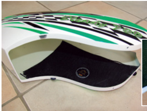
Die Rumpfteile sind gezielt mit Carbon-Fasern (=> höhere Steifigkeit, niedrigeres Gewicht) verstärkt
