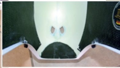
Die Rumpfteile sind gezielt mit Carbon-Fasern (=> höhere Steifigkeit, niedrigeres Gewicht) verstärkt
