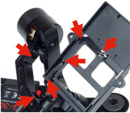
Potenzielle Scheuerstellen der Kabel müssen regelmäßig kontrolliert werden. Ein Kurzschluss gegen das Metall kann den Kopter gefährden. Vorsicht beim Einsetzen der Kamera
