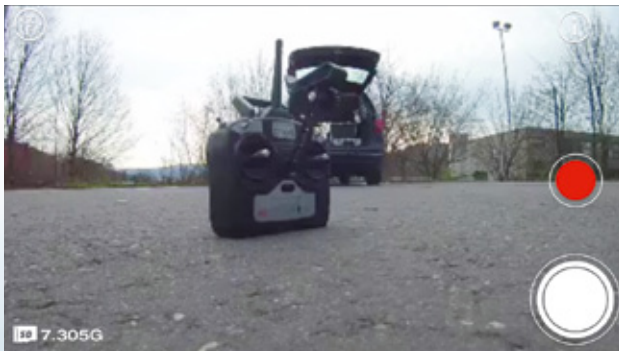
Die App mit dem Live-Kamerabild. Unten links werden der freie Kartenspeicherplatz, darüber die Video-Auflösung (hier 60FPS) angezeigt. Der rote Button startet die Video-Aufnahme, darunter der (Still-)Foto-Auslöser
