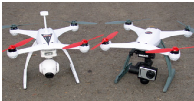
Rechts der Blade QX2 mit Zweiachs-Gimbal und CGO1, daneben der aktuelle QX3 mit Dreiachs-Gimbal und CGO2-Full-HD-Kamera. So ausgerüstet, ist der QX3 sogar noch um 59 Gramm leichter als der QX2
