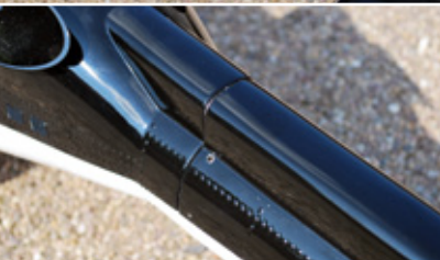
Trennstelle zwischen Hauptumpf und Heckausleger – so wird das Ganze miteinander verbunden. Zum Schluss wird noch die Verschraubung vorgenommen
