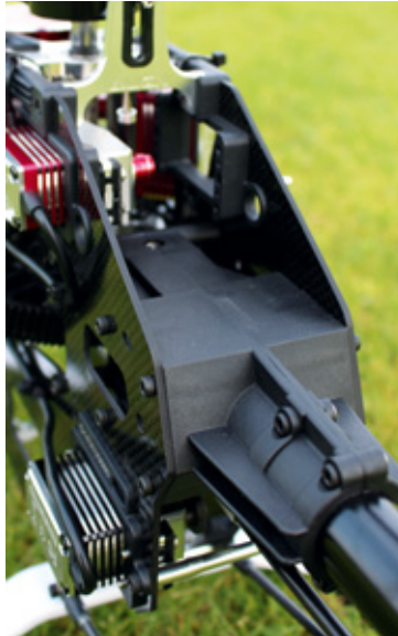
Die robust dimensionierte Heckrohr-aufnahme mit integriertem Heckabtrieb
