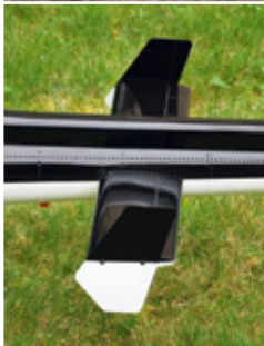
Die Montage der kleinen Höhenleitwerks-Endscheiben erfolgt mit jeweils zwei Schrauben und UHU Plus. Bei der Montage wird ein Winkel verwendet. Die Schraubchen müssen hierbei gefühlvoll angezogen werden
