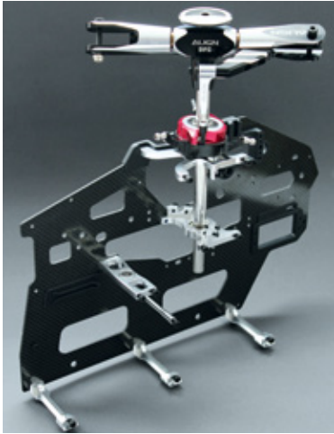
Verdeutlichung des Chassis-Aufbaus mit der doppelt gelagerten Rotorwelle und Alu-Verbindern
