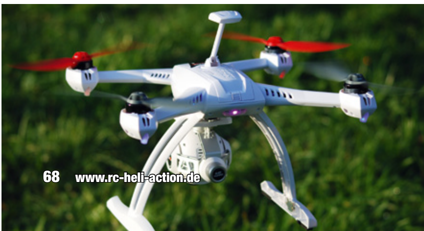
Befestigt wird das Gimbal am Kopter mit Hilfe eines Schienensystems
