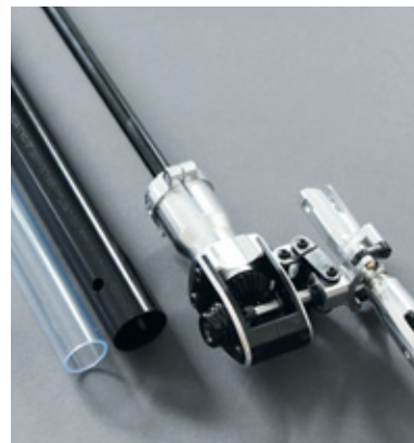
Der Heckantrieb erfolgt über Starrwelle, die im Heckrohr zwischengelagert wird
