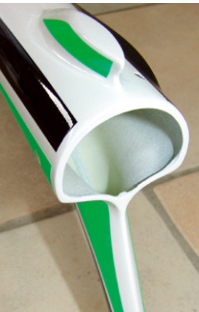
Ein umlaufender Abschlusskragen versteift die Rumpfföffnung im Bereich des Heckrotors
