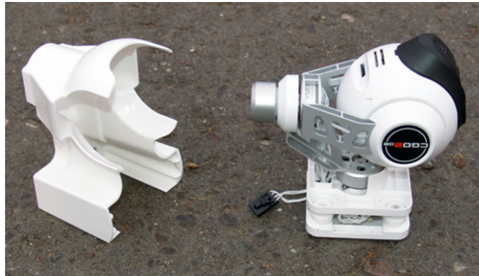
Das Dreifachs-Gimbal wird betriebsfertig inklusive Befestigungsplatten ausgeliefert, die mit Gummiringen voneinander entkoppelt sind. Die Schutzkappe sollte man nicht wegwerfen – sie dient als Transportschutz
