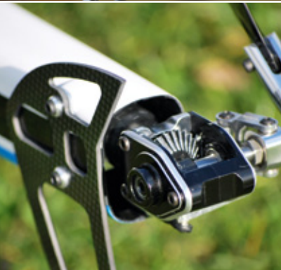
Heckrotor, Heckrohr und Heckverkleidung werden fest miteinander verschraubt. Als Abstandshalter wird der Original-Abstandshalter des T-Rex-700-Seitenleitwerks verwendet. Das Gestänge wird innerhalb der Verkleidung geführt
