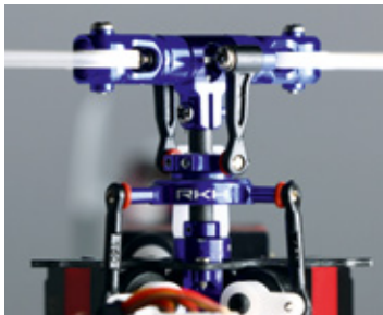
Der DFC-Kopf nebst Tuning-Taumelscheibe. Deutlich zu erkennen sind die hinter den Kugelgelenken sitzenden O-Ringe
