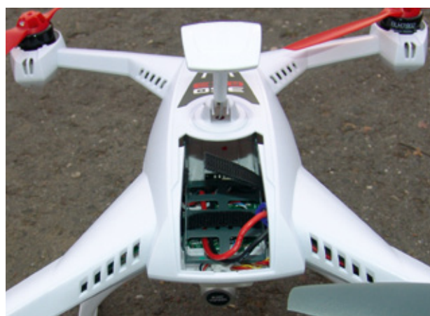
Zum Einsetzen des 3.000er-LiPos muss die GPS-Antenne hochgeklappt sein
