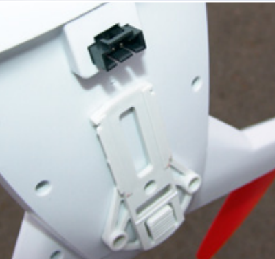
Die Unterseite des Blade QX3 AP mit der Anschlussbuchse und der Aufnahmeplatte für das Gimbal
