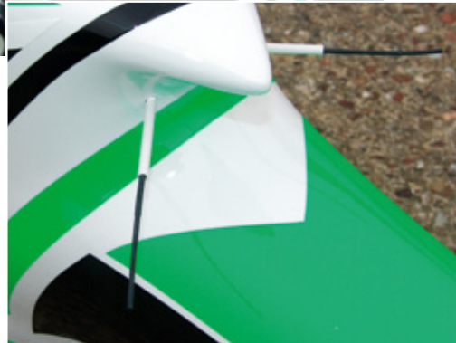
Der Empfangs-Satellit VBar-Control sitzt hinter der Rotorwelle. Seine Antennenenden stehen im 90-Grad-Winkel zueinander im Freien
