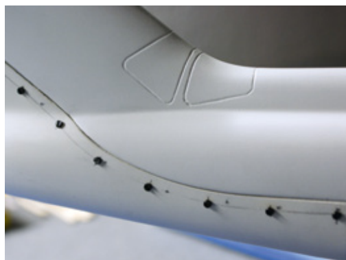
Der am hochgesetzten Heckausleger verschraubte Revisions-Deckel gewährt nach Demontage Zugang zum Heckantrieb
