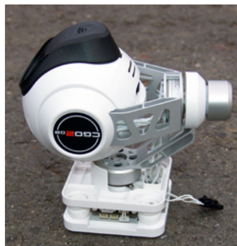
Elegante und sehr leichte Bauweise: Deutlich zu erkennen sind die mit gewichtsmindernden Aussparungen versehenen, haudünnen und doppelt ausgeführten Trägerarme aus Aluminium
