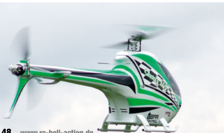
Ein umlaufender Abschlusskragen versteift die Rumpfföffnung im Bereich des Heckrotors
