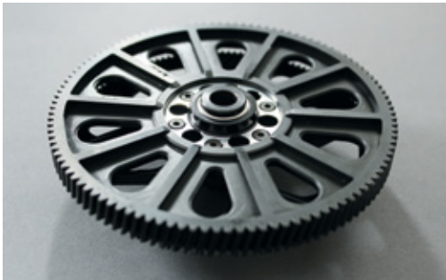
Das schrägverzahnte Hauptzahnrad mit integriertem Freilauf für in der Autorotation mitdrehenden Heckrotor
