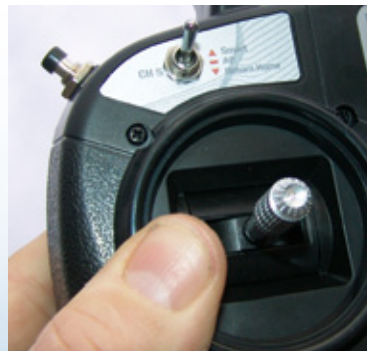
Der linke Dreizeige-Schalter der DX4 dient zum Aktivieren von Smart, AP und Return Home. An der Stirnseite der Tastschalter zum Stoppen der Motoren
