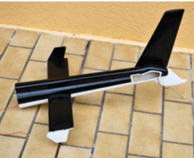
Der mit Beleuchtungs-Verlängerungskabel, Seitenleitwerk und Sporn versehene Heckausleger ist zur Hochzeit mit dem Rumpf bereit
