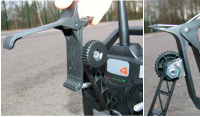
Der Smartphone-Haltebügel besteht aus Kunststoff, die Klammer ist schwenkbar
