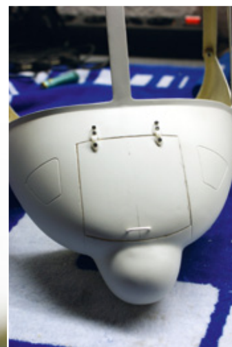
Die Wartungsklappe in der Rumpfnase wurde funktionstüchtig mit Scharnieren versehen. Die Arretierung erfolgt mittels eingelassener Magnete
