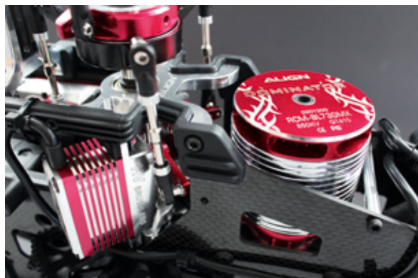
Wie bei 700er-Helis: Die Servos haben Metall-Ruderhebel, die Gestänge sind robust ausgeführt
