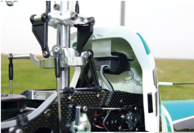
Der Empfangs-Satellit VBar-Control sitzt hinter der Rotorwelle. Seine Antennenenden stehen im 90-Grad-Winkel zueinander im Freien
