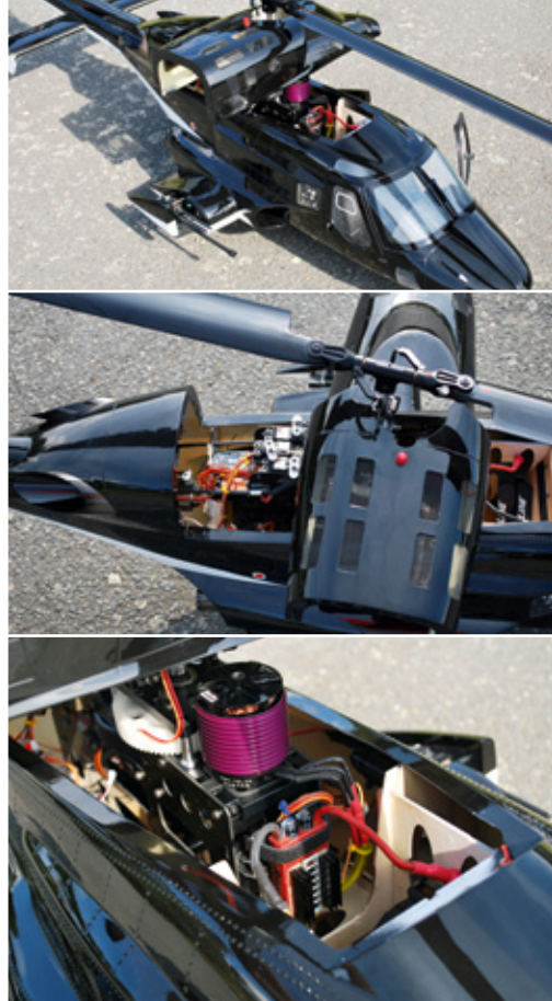
Nach Montage des Hauptrotorkopfs kann der obere Deckel nicht mehr abgenommen werden. Zum Einsetzen der Akkus wird er um 90 Grad gedreht, dabei kommt man an Controller und Motor sehr gut heran
