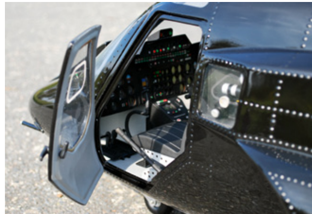
Die Seitenkameras werden in einen vorgegebenen Rahmen im Rumpf eingeklebt – eingebaut sieht es sehr gut aus
