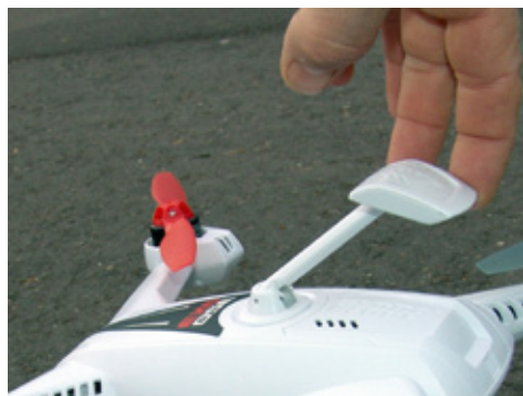
Der ausklappbare GPS-Mast optimiert die GPS-Empfangsbedingungen
