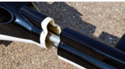
Der mit Beleuchtungs-Verlängerungskabel, Seitenleitwerk und Sporn versehene Heckausleger ist zur Hochzeit mit dem Rumpf bereit
