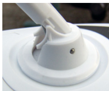
Zwei kleine Nasen sorgen in ausgeklapptem Zustand dafür, dass die Antenne sicher einrastet
