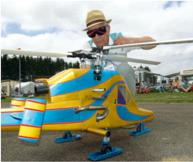
Der Autor Ernst Wieland nach erfolgreicher Flugprobung mit seinem selbstgebaute Kaman K-MAX im Maßstab 1:7,1. Die Daten: Rotordurchmesser 2 x 1.520 mm, Antrieb über 23er-Benzinmotor und Abfluggewicht 9.500 Gramm
