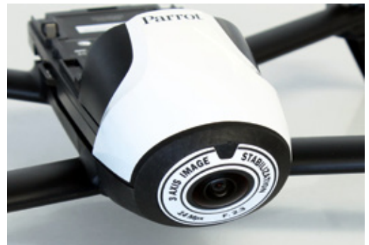
Die in der Bebop 2 verbaute Kamera verfügt über einen 14-Megapixel Sensor und erstellt Videos in Full-HD
