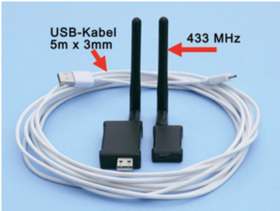
Abbildung 1: Die Anbindung des Kopters an den PC erfolgt mit USB-Kabel oder Telemetrie-Modulen. Die Micro-USB-Buchse am Kopter darf dabei keinesfalls belastet und gebogen werden
