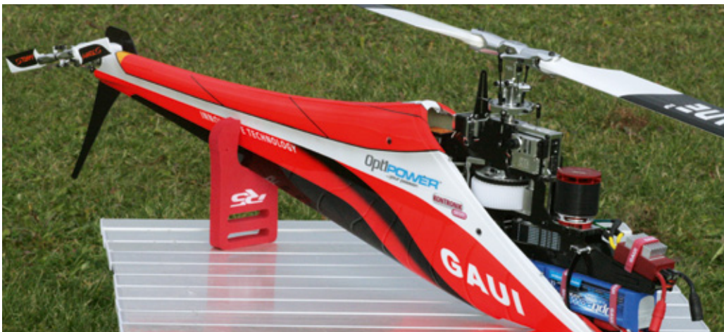
Mittels einer umgedrehten Rotorblattstütze lässt sich höhere Standsicherheit erreichen
