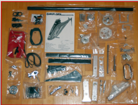
Die sauber gefertigten Einzelteile der R5-Mechanik. Die Schrauben sind zwar übersichtlich verpackt, aber leider nicht nach Baugruppen geordnet. So muss man sich vor jedem Bauabschnitt die einzelnen Komponenten zusammensuchen
