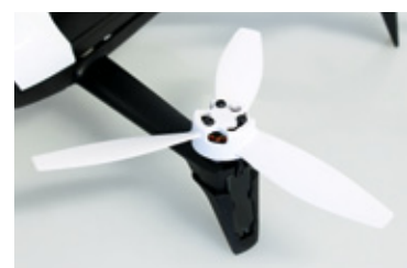
Die Propeller können schnell und einfach gewechselt werden. Einfach aufsetzen und durch Drehen arretieren
