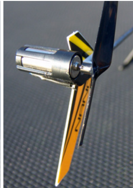
Der drehzahlgesteuerte Heckrotor des Nano CP S wurde vom Blade Nano CP X übernommen
