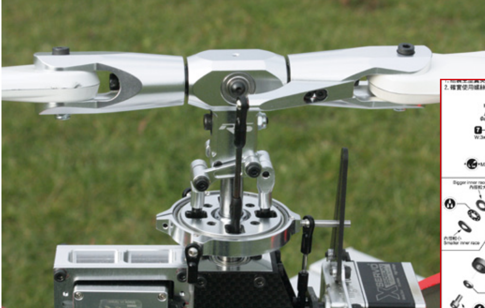
Der Rotormast mit seinem Alu-Hauptrotor ist vormontiert und baut extrem flach
