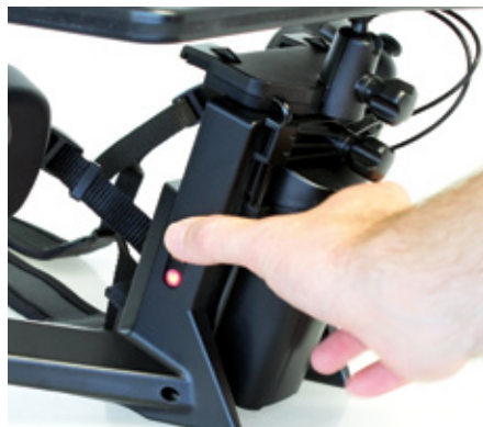
Der große Ein-aus-Schalter ist mit einer LED versehen, die während des Flugs die Lage-Erkennung vereinfacht
