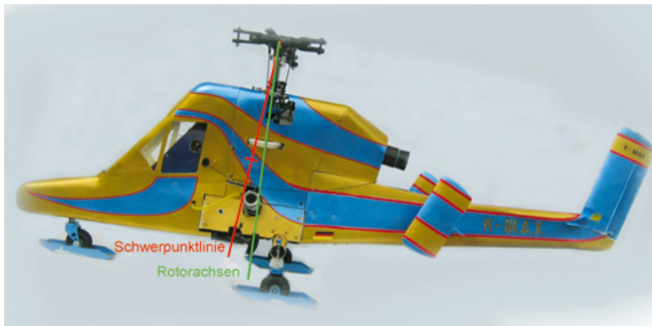
Abbildung 1: K-MAX Brustschwimmer – Rückwärtsflug Rückenschwimmer: inhärentes Nickmoment führt zum Auf-Nicken Grün: Rotorachsen mit Antriebsleistung. Rot: Schwerpunktlinie. Die Rotoren drehen im Rückwärtsflug entgegengesetzt (wie beim Rückenschwimmer). Der Schwerpunkt befindet sich in Flugrichtung hinter der Rotorachse (Instabilität). Das Höhenleitwerk wird – wenn überhaupt – von hinten angeströmt. Das Seitenleitwerk bewirkt negative Richtungsstabilität
