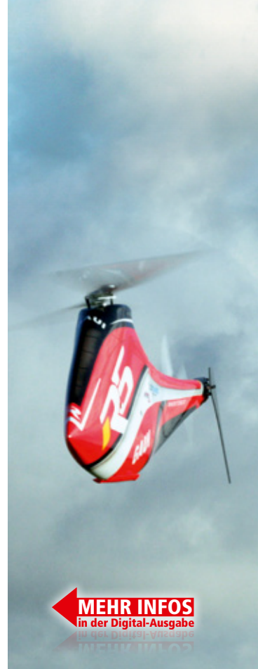
Mittels einer umgedrehten Rotorblattstütze lässt sich höhere Standsicherheit erreichen
