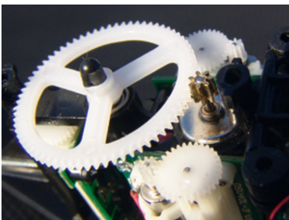
Blick aufs einstufige Getriebe sowie die Spindelantriebe der Linear-Servos
