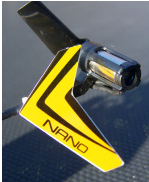
Der drehzahlgesteuerte Heckrotor des Nano CP S wurde vom Blade Nano CP X übernommen
