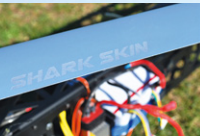
Die Shark Skin-Rotorblätter von Vario sind halbsymmetrische GFK-Blätter mit einer Länge von 680 Millimeter. Die Schrift befindet sich immer auf der Oberseite
