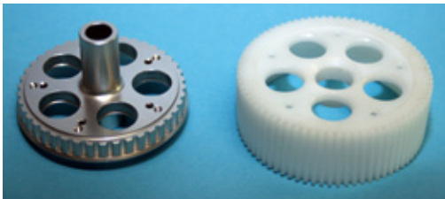
Mehr als stabil: Das Delrin-Hauptzahnrad der zweiten Getriebestufe und das Alu-Riemenrad für den Heckantrieb
