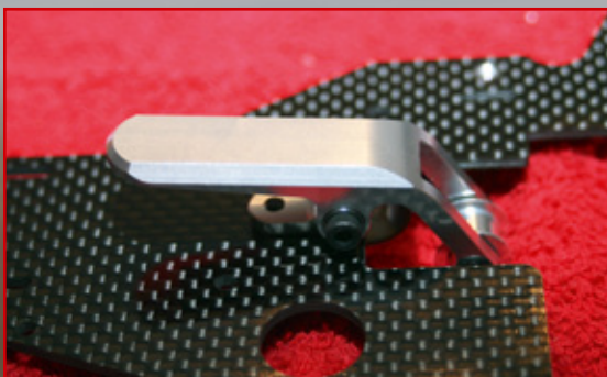
Sehr gut gelöst: Der Heckrotor-Riemenspanner hat zum Entlasten einen gut zugänglichen Hebel ...
