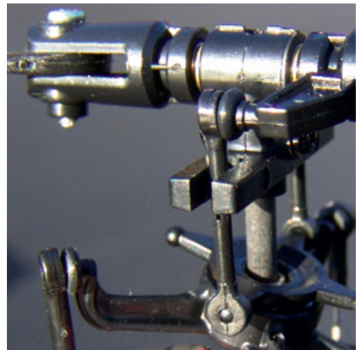
Hinter den Kugelgelenken am Taumelscheiben-Außenring und am Blattverstellarm sitzen winzige O-Ringe, um einen Gegendruck aufzubauen und somit das Spiel zu minimieren
