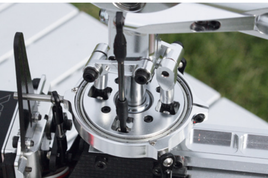
Die extrem flache Alu-Taumelscheibe mit den innenliegenden Kugelschlüssen
