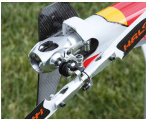
Der riemengetriebene Heckrotor mit seinem Alu-Gehäuse sorgt für gute Hochachsen-Performance
