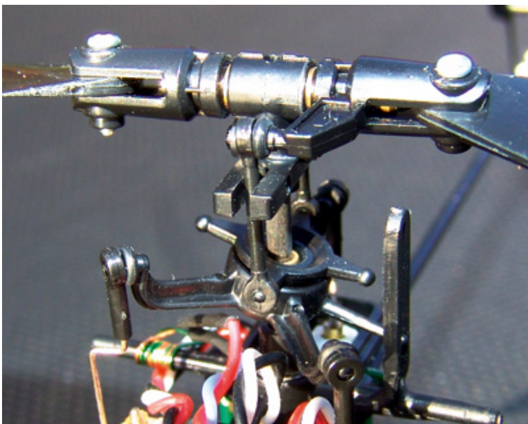
Hinter den Kugelgelenken am Taumelscheiben-Außenring und am Blattverstellarm sitzen winzige O-Ringe, um einen Gegendruck aufzubauen und somit das Spiel zu minimieren
