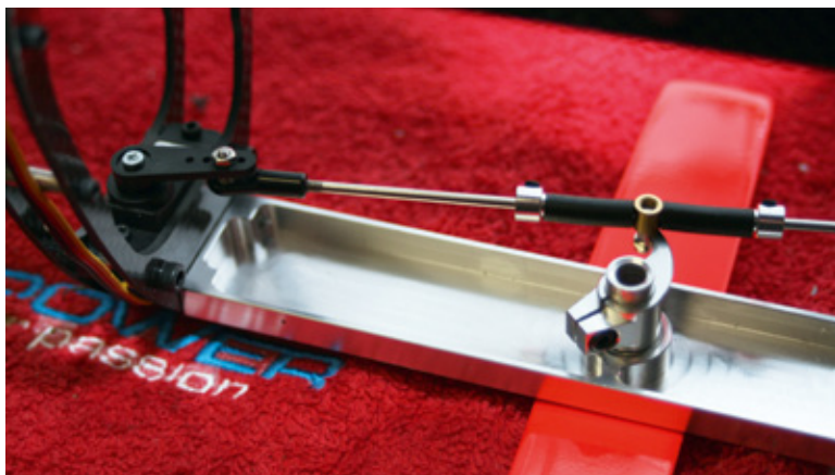
Der drehbare Balken, der als Landewerk dient und von einem Servo bedient wird. Entgegen der Gaiu-Anleitung wurde die Anlenkung so justiert, dass im ausgefahrenen Zustand Servohebel und Gestänge in einer Linie liegen. Das entlastet das Servogetriebe
