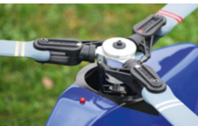
Zusätzlich wurden Blatthalter und Blätter markiert, um Verwechslungen bei der Montage auszuschließen
