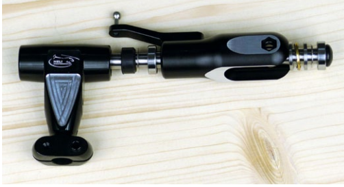
In den Blattgriffen kommen je zwei Radial- und ein Axiallager zum Einsatz. Die Dämpfung ist eher hart abgestimmt, funktioniert aber auch bei niedrigen Drehzahlen einwandfrei
