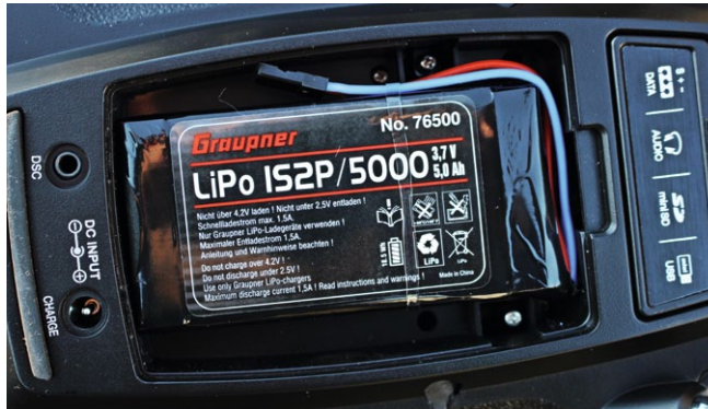
Der neue LiPo-Senderakku 1s2p hat mit 5.000 Milliamperestunden nicht nur mehr Kapazität, sind auch dickere Silikonkabel als der mz-24-Akku
