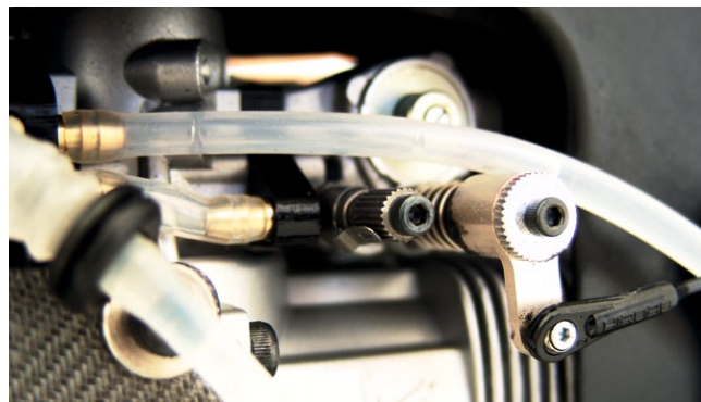
Wie aufwendig sich seinerzeit das Setup eines Helis gestalten konnte, wird auch an dieser RC-Düsenadel-Verstellung deutlich, mit der das Kraftstoffgemisch während des Flugs optimiert werden konnte. Es handelt sich hier um den Yamada 91 ST, eingebaut im Black Shark von Manabu Hashimoto
