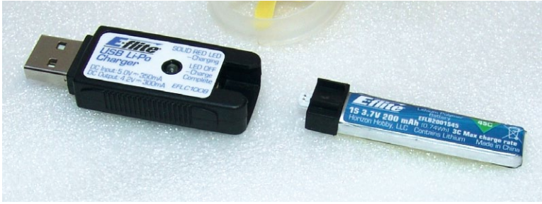
Der 200er-LiPo-Akku wird mit dem beiliegenden USB-Adapter aufgeladen
