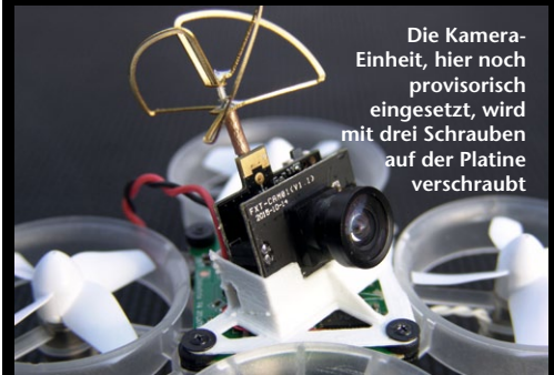
Mit dem FPV-Kit von FlyingMachines ( www.flyingmachines.de ) lässt sich der Inductrix auf Tiny Whoop umbauen. Im Wesentlichen sind dies Kamera, Motoren und Kamerahalter
