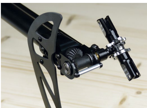
Der Heckrotor mit seinen großen Kegelrädern ist sehr robust. Die Anlenkung erfolgt über einen Torsionsstab
