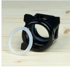
Das Heckrotorgehäuse sitzt von zwei O-Ringen gedämpft auf dem Heckrohr. So sollen schädliche Vibrationen von der Mechanik entkoppelt werden
