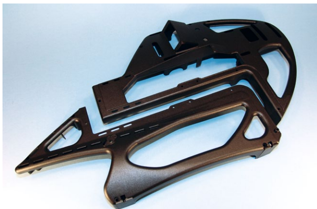
Das Chassis bilden spritzgegossene Halbschalen, die als Ober- und Unterteil ausgeführt sind (Gewicht je Paar: 320/144g)
