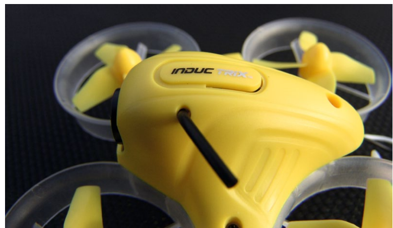
Der mit Schriftzug versehene Tastschalter dient zum Umschalten des Video-Kanals. Die Antenne (schwarz) ist seitlich herausgeführt
