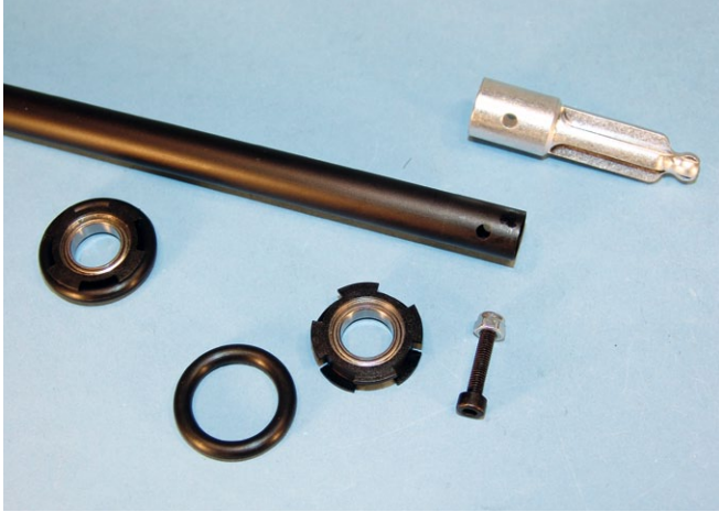
Der Starrantrieb zum Heck (10 mm Alu) ist selbstanschließend
