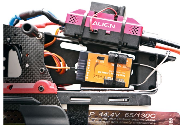
Will man Zusatz-Features wie Governor und Attitude Control im Microbeast nutzen, ist ein Summensignal-Empfänger praktisch Pflicht. Hier der bewährte und sehr günstige BeastRX, der via SRXL-Datenausgang mit dem Microbeast kommuniziert
