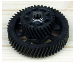
Das Zwischengetriebe des Soxos kam seinerzeit auch so in den 700ern zum Einsatz und dürfte von daher in einem 550er nahezu unkaputtbar sein. Die Kugellager sitzen bei diesem Getriebe in den Zahnradern – die Welle sitzt fest im Chassis
