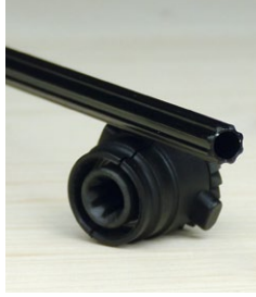
Der Heckrotor wird von einer sternförmigen Welle angetrieben, die direkt in die gespritzten Kunststoffritzel greift
