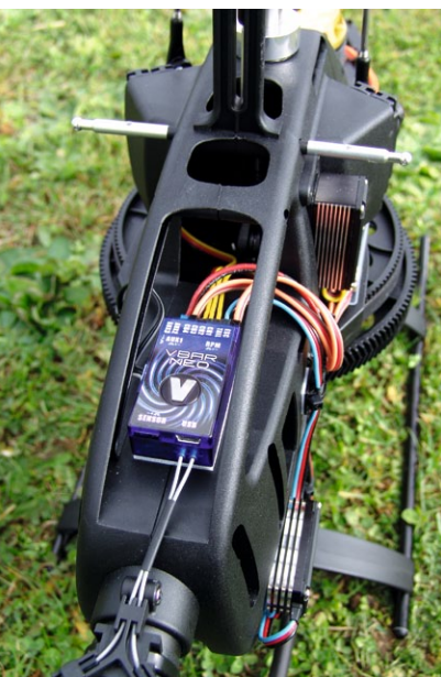
Das VStabi Neo an seinem Arbeitsplatz im Heck der Maschine. Der kurze Schrumpfschlauch-Abschnitt um die Antennenleitungen vermeidet ein Einklemmen beim Zuschneiden der Kabinenhaube
