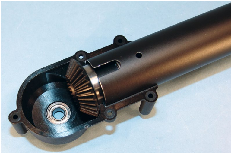
Kompaktbauweise: Die nur 26 Gramm leichten Halbschalen des Heckgetriebes nehmen das Zahnrad samt Lagerung im Inneren des Heckrohrs auf
