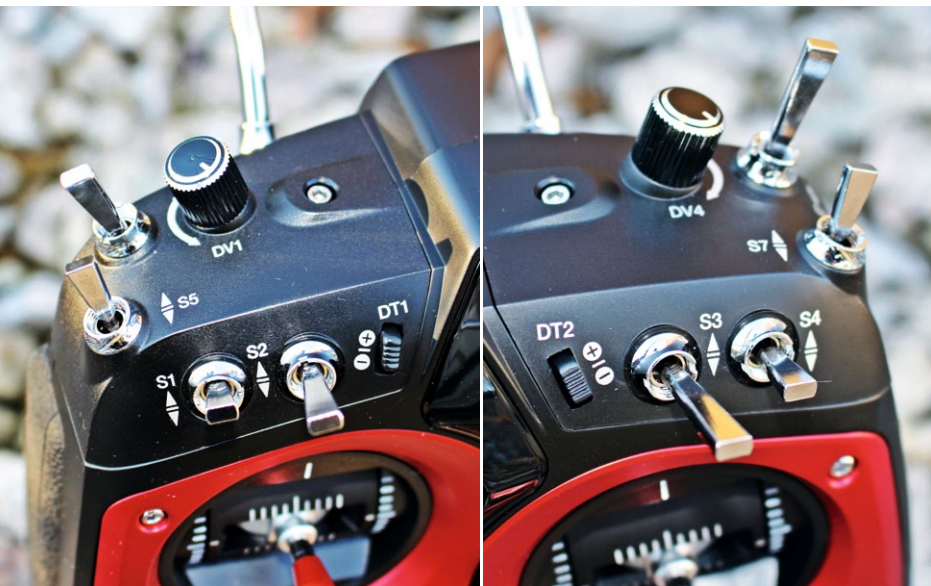
Alle serienmäßig bereits eingebauten Schalter und Drehgeber auf der Stirnseite des Senders können via Software den jeweiligen Funktionen frei zugeordnet werden
