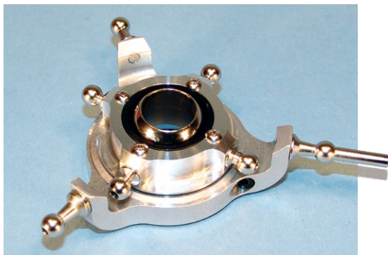
Vollmetall-Taumelscheibe mit verchromter Kugel des Schwenkgelenks und die ultraleichten Lagerplatten des Motors
