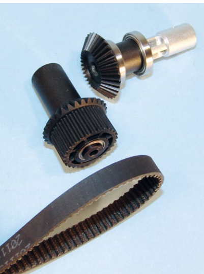
Der Heckantrieb erfolgt über einen Zahnriemen vom Hauptrotor auf ein Winkelgetriebe und dann weiter mit Starrwelle zum Heck
