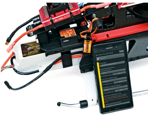
Das Bluetooth-Interface BLE2SYS erlaubt ein sehr komfortables Fine-Tuning des Modells auf dem Flugfeld. Schon nach kurzer Zeit möchte man es nicht mehr missen
