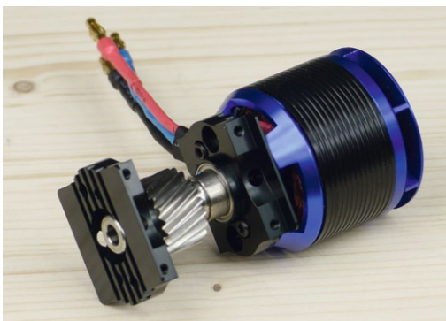
Der Xelaris-Motor mit Motorträger, schrägverzahntem Ritzel und Gegenlager. In Motorträger und Gegenlager sitzt je ein 10er-Kugellager für das Ritzel
