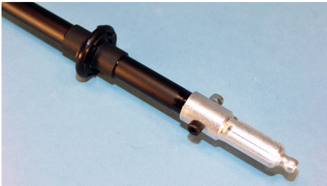
Die Wellenlager werden durch innen selbstklebende Schrumpfschlauch-Abschnitte in Position gehalten
