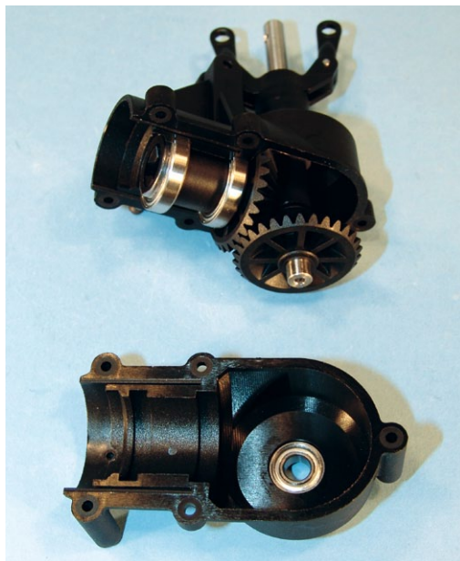
Das Kegelzahnrad ist direkt auf die Heckrotorwelle gespritzt, somit kann eine separate Befestigung durch einen Stift entfallen
