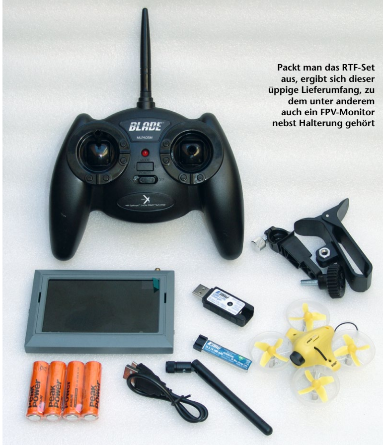
Markant ist die in der gelben Haube sitzende Kamera nebst FPV-Sender. Die Basis-Mechanik (Chassis) stammt vom Inductrix
