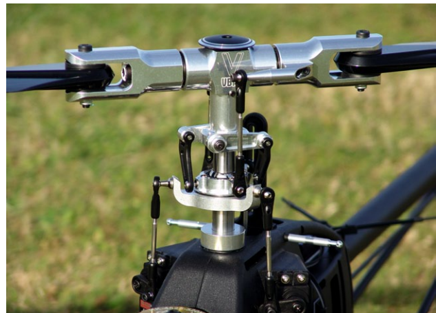
Die Öffnung der Blattgriffe wird mit Distanzscheiben auf das passende Maß von 12 Millimeter gebracht
