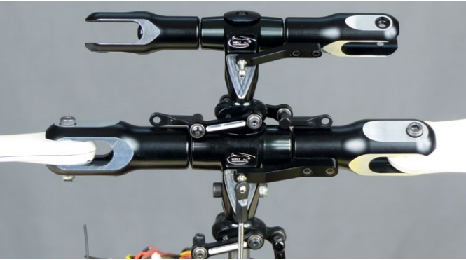
Rotorkopf-Vergleich: Der Rotorkopf des 550ers (oben) wirkt wie eine geschrumpfte Version des 700er-Exemplars (unten)
