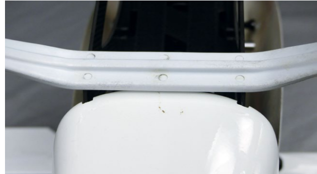
Die Haube saß beim Testmodell unten auf Spannung an den CFK-Seitenplatten. Damit es hier nicht auf Dauer zum Einreißen kommt, wurde sie leicht ausgenommen
