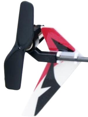
Simple, aber effiziente Heckrotor-Konstruktion mit eigenem Bürstenmotor und einer direkt auf der Motorwelle aufgespressten Luftschraube
