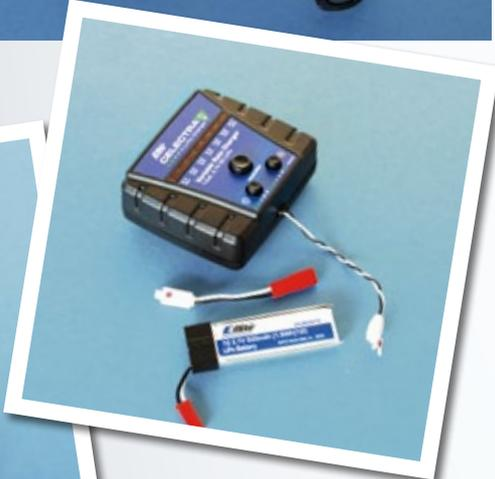
Der beiliegende 1s-Flugakku mit einer Kapazität von 500 Milliampere-stunden kann mit dem Celectra-Ladegerät wieder gefüllt werden. Der Lader realisiert einen Ladestrom von 700 Milliamperestunden und füllt den Akku in weniger als einer Dreiviertelstunde
