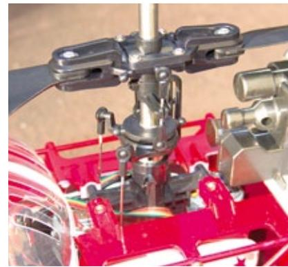
Die Anlenkung des unteren Rotors erfolgt über zwei Gestänge, die sauber in einer Führung laufen und mit der darunterliegenden Taumelscheibe verbunden sind. Die Servos für Nick und Roll sitzen in der Einbaumechanik
