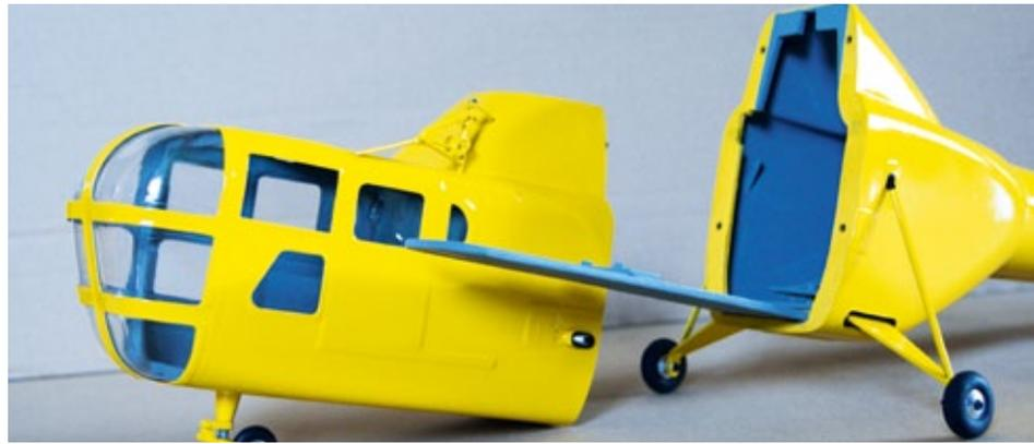
Der Rumpf unmittelbar nach der Lackierung. Durch die geschickte Trennung des Rumpfs in zwei Hälften ist das Einschieben der Mechanik ein Kinderspiel
