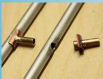
Zur Verbindung von Kufenrohren und Kufenbügel dienen kurze Messinghülsen mit angelöteten Blechmanschetten
