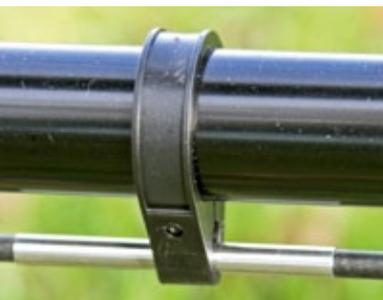
Durch übergestülpte Aluminium-Hülsen wird der Carbonstab der Heckrotor-Anlenkung vor Abrieb geschützt
