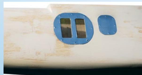
Einzelne Details wurden aus Lithoblech angefertigt und auf den Rumpf geklebt
