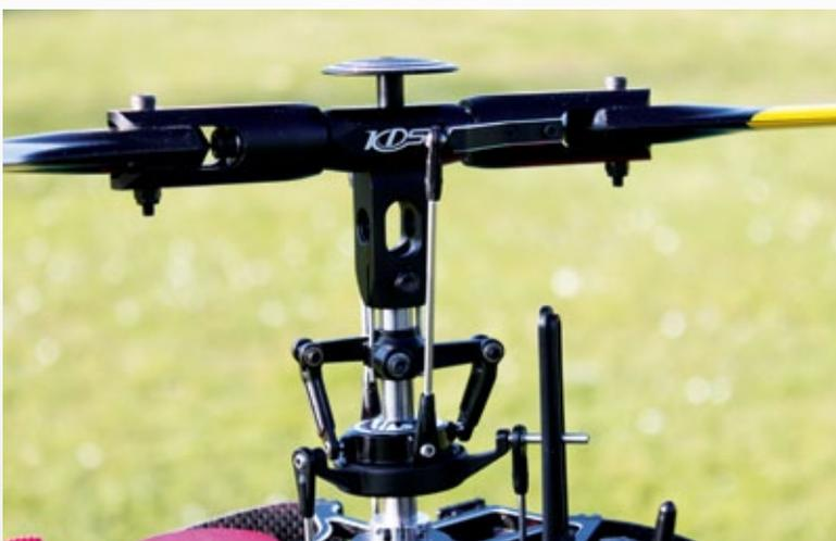
Das Rotorkopf-Zentralstück des Flybarless-Hauptrotors ist baugleich mit der Paddelvariante und baut dementsprechend hoch. Vorteil: Beim Umrüsten von Paddel auf Flybarless werden nur sehr wenige Bauteile benötigt
