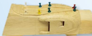
Die fertig verschliffene Triebwerks-Verkleidung mit Lufteinläufen und Abgaskühlanlage. Oben werden zusätzliche Balsastreifen aufgeklebt, die später die Basis für das Doghouse bilden
