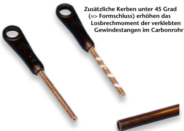
Zusätzliche Kerben unter 45 Grad (= > Formschluss) erhöhen das Losbrechmoment der verklebten Gewindestangen im Carbonrohr
