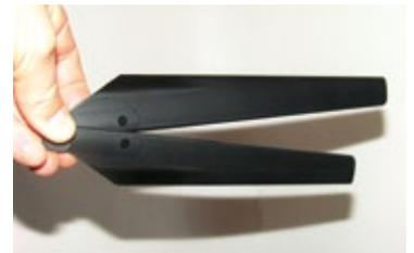
Kein Versehen, sondern konstruktiv so gewollt: Oberer und unterer Rotor haben verschiedene Blattlängen. Sie differieren um 30 Millimeter
