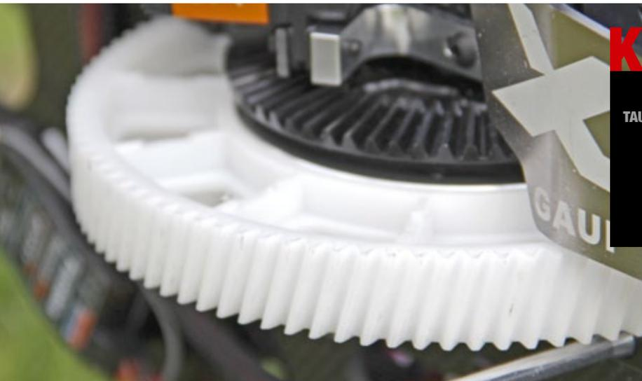
Das schrägverzahnte Hauptzahnrad im Modul 1,2 hält selbst den härtesten Belastungen stand. Deutlich zu erkennen ist auch das darüber befindliche Tellerzahnrad für den Heckrotor-Abtrieb
