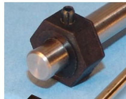
Um das Spiel zwischen Wellenbohrung und Riemenrad-Mitnehmer herauszunehmen, kann der Zylinderstift durch einen Spannstift zum Toleranzausgleich ersetzt werden
