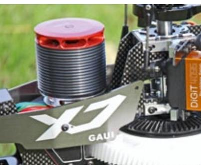
Die seitlichen Platten am Motorträger dienen nicht nur der Optik, sondern tragen auch zur Wärmeabfuhr bei
