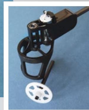
Das Kunststoff-Hauptzahnrad ist auf einer Motorwelle aus Carbon platziert. Letztere ist kugelgelagert in den Motorhaltern gelagert
