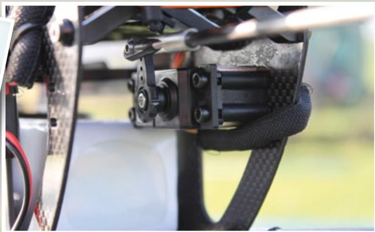
Einbau des KDS 690-Heckservos. Auch hier ist die Performance vorbildlich. Bei der Verwendung von Akkus über 4.000 Milliamperestunden Kapazität wird es hier allerdings recht eng
