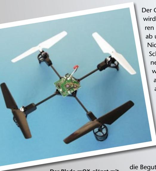
Der Blade mQX glänzt mit seinem einfachen Aufbau. Unter der Haube kommt die Hauptplatine zum Vorschein. Diese ist auf einem Rahmen-Mittelteil verschraubt, das wiederum die vier Ausleger aufnimmt
