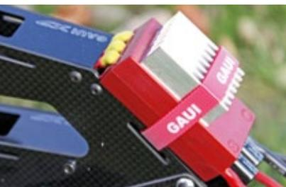
Der HeliJive mit passendem Kühlkörper findet auf der vorgesehenen Plattform halt
