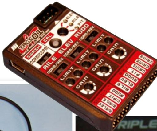
Die Intelligenz des TAGS01 sitzt in der Elektronik-Box. Ihre Einstell-Oberfläche ist in drei Bereiche gegliedert: Roll (Ail), Nick (Elev) und Heck (Rudd). Der „Cal“-Button leitet die Kalibrierung ein, bei der mit dem Wahlschalter die Funktion ausgewählt wird
