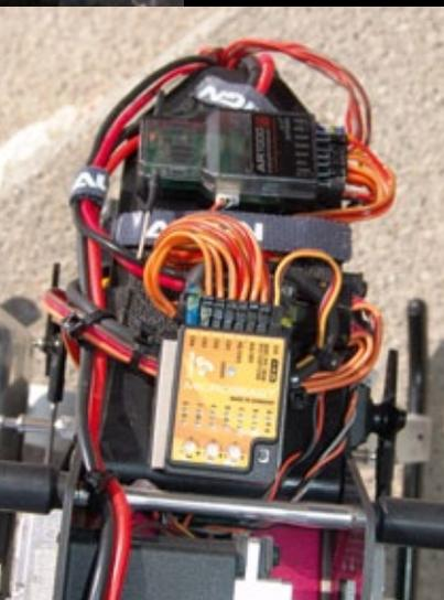
Beispielverdrahtung in Verbindung mit einem „Normal“-Empfänger Spektrum AR7000, dessen Anschlussbuchsen weitestgehend belegt sind
