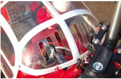
In der Kanzel sind Lüftungsschlitze für die darunter liegende Bordelektronik eingearbeitet
