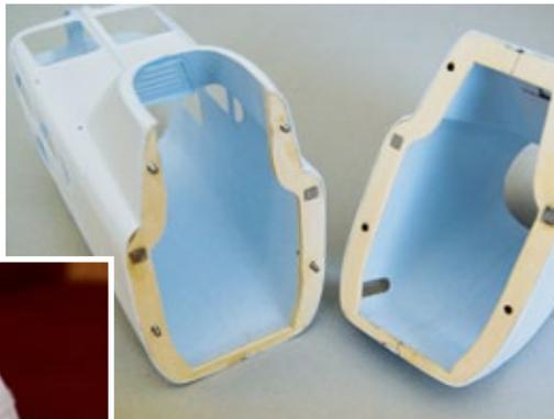
Die Trennung des Rumpfs erfolgt normalerweise an der rot gestrichelten Linie, sodass eine untere Rumpfbotschale bestehen bleibt. Zugunsten besserer Zugänglichkeit wurde jedoch das komplette Rumpfvorderteil abnehmbar gestaltet
