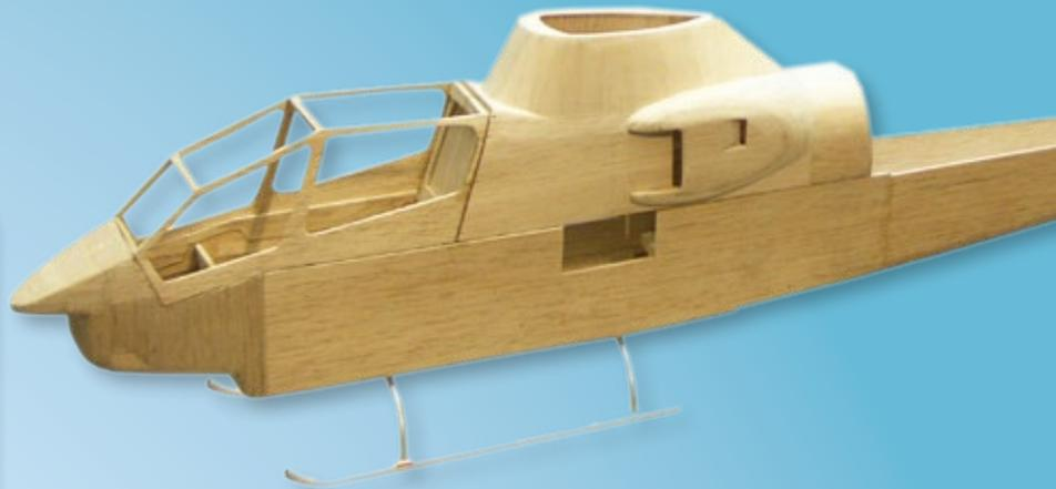
Rumpfwanne mit aufgesetzter Kanzel und Triebwerks-Verkleidung. Die Aussparungen in der Rumpfwanne sind wegen dem Hauptzahnrad der Mechanik erforderlich und werden später von den Stummelflügeln verdeckt
