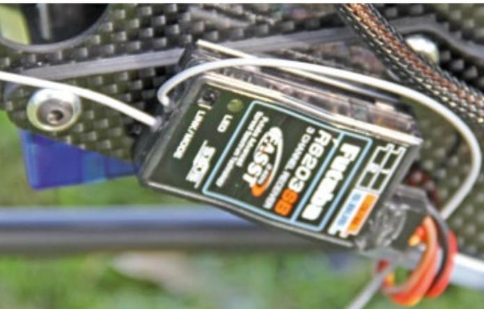
Klein, aber oho. Der Empfänger des Typs R6203SB wird mit nur einem Kabel mit dem V-Stabi verbunden. Eine zweite, zusätzliche Leitung dient zur Verbindung mit dem Hercules BEC
