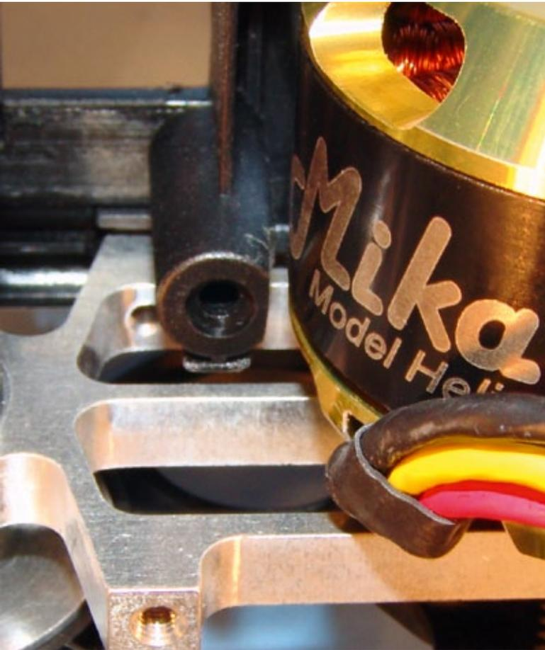
Eine gefeilte Aussparung im unteren Teil der Verschraubung ermöglicht es, den großen Mikado/Scorpion-Motor näher an das Hauptzahnrad heranzuschieben
