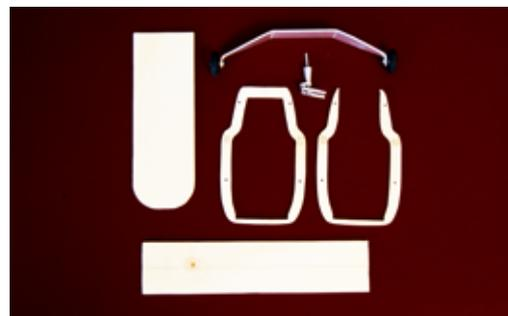
Hier das Fahrwerk und die Holzteile zur Fertigstellung des Rumpfs. Die großen Spanten dienen zur Verstärkung im Bereich der Trennebene
