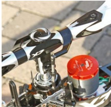
Der Flybarless-Hauptrotorkopf ist nicht nur optisch gelungen, sondern auch äußerst robust konstruiert. Deutlich zu erkennen: die Führung der Rotorkopf-Gestänge
