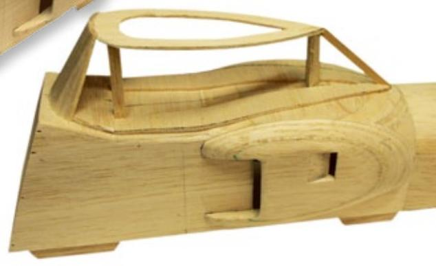
Das Grundgerüst des Doghouse. Die eigentliche Stabilität entsteht, indem ringsum Balsastreifen angeklebt werden. Später wird der Zwischenboden von innen ausgeschnitten, damit die Rotorwelle mit der Taumelscheibe durchgesteckt werden kann
