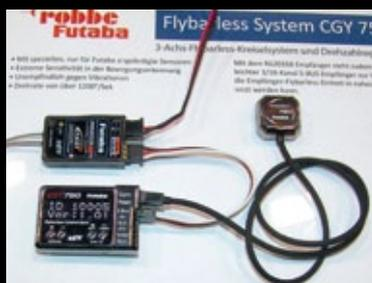
Beispielanschluss für das Futaba S-Bus-System, bei dem es ebenfalls nur eine Impulsleitung (Summensignal) gibt, die Empfänger und Flybarless-System miteinander verbinden
