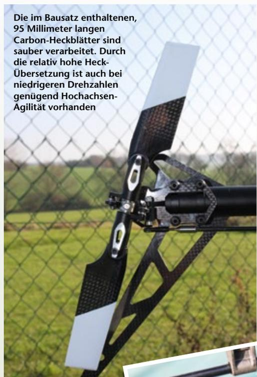
Die im Bausatz enthaltenen, 95 Millimeter langen Carbon-Heckblätter sind sauber verarbeitet. Durch die relativ hohe Heck-Übersetzung ist auch bei niedrigeren Drehzahlen genügend Hochachsen-Agilität vorhanden
