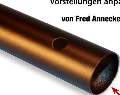
Die Innenkanten des Heckrohrs sollten angefasst werden, um eine Stolperstelle für den Riemen bei zu wenig Vorspannung zu vermeiden
