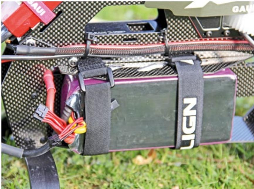
Die durchdachte Akku-Aufnahme ermöglicht einen Wechsel der beiden 6s-LiPos binnen wenigen Sekunden
