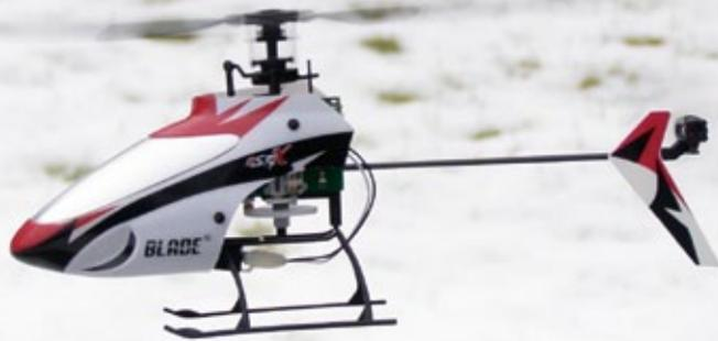
erst gewöhnen muss, wenn man gekapselte Servos und Alu-Teile gewohnt ist. Dabei ist aber immer im Auge zu behalten, dass diese leichte Konstruktion eine enorme Crash-Festigkeit ermöglicht. Mit seiner eleganten halbdurchlässigen, silbernen Kabinenhaube, den fehlenden Paddeln und den gegenüber dem Vorgänger schlankeren Rotorblättern macht der mSR X keine schlechte Figur.
