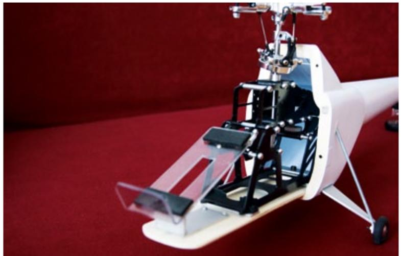
Probeweises Einsetzen der Mechanik, die mit ihrer unteren Lagerleiste hinten in der Kupplung arretiert und vorne mit dem langen Bodenspannt verschraubt wird
