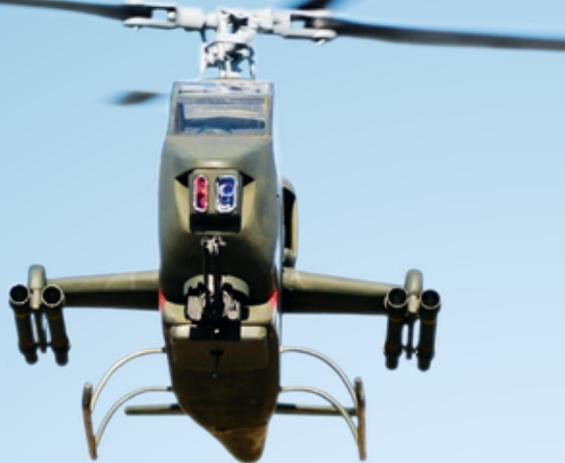
Zum Schluss wurde das Kufenlandegestell der Länge nach in zwei Hälften zersägt, sodass sich die halbierten Kufenbügel seitlich in die dafür vorgesehenen Aufnahmen am Rumpf stecken ließen. Da sie in den Holzblöcken sehr stramm sitzen, ist keine weitere Befestigung erforderlich.
