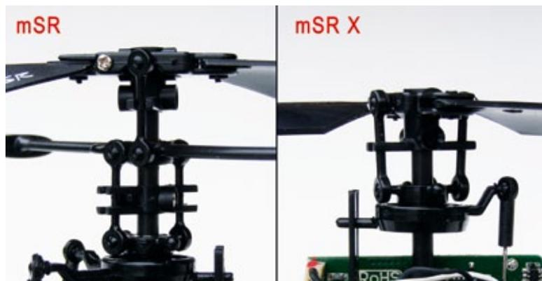
Rotorkopf-Vergleich. Links der Paddelkopf des bisherigen Blade mSR, daneben die deutlich flacher bauende, neue Flybarless-Version des Blade mSR X
