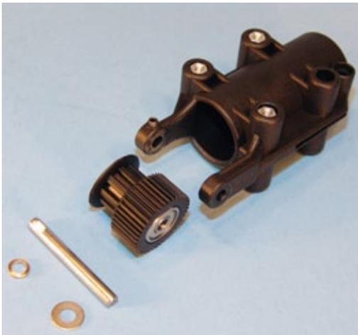
Das Kombirad für den Heckantrieb wird am besten zwischen unterschiedlich großen Scheiben zentriert, die an die Abmessungen der Kugellager im Rad angepasst sind
