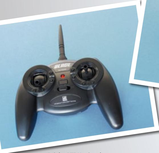
Bei der RTF-Version des Blade mQX liegt ein MLP-4DSM Vierkanalsender bei. Dieser verfügt über einen Ein-Aus-Schalter, eine Status-LED sowie Kreuzknüppel mit digitalen Trimmungen
