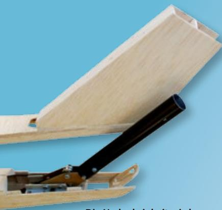
Die Umlenkeinheit wird mit zwei Aluwinkeln im Heck des Holzrumpfs verschraubt. Ein kurzes Stück des Heckrohrs und die komplette Eco8-Heckrotoreinheit werden in der Cobra weiterverwendet. Im Hintergrund steht die rohbaufertige Heckrotor-Verkleidung bereit
