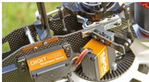
Das im Chassis verschraubte Nickservo sitzt unterhalb der Taumelscheiben-Führung
