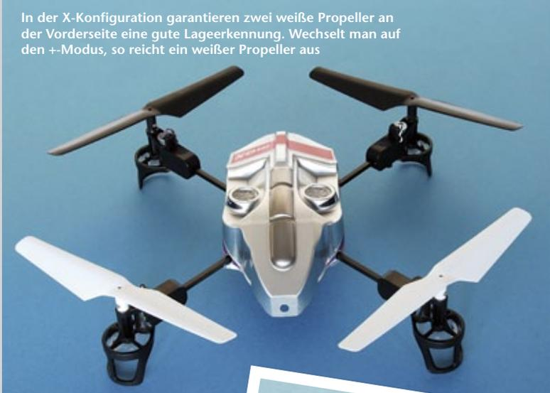
In der X-Konfiguration garantieren zwei weiße Propeller an der Vorderseite eine gute Lageerkennung. Wechselt man auf den +-Modus, so reicht ein weißer Propeller aus
