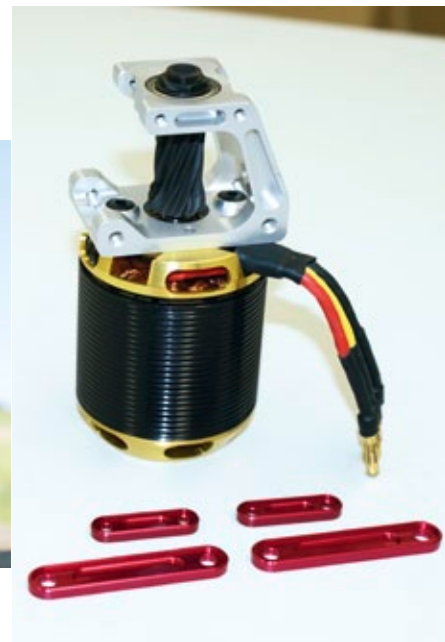
Blick auf den hinten im Chassis sitzenden Scorpion-Außenläufer, der mit einer Ritzelabstützung versehen ist
