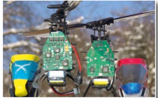
Platinenvergleich mCP X BL vs. mCP X; links die BL-Ausführung mit den oben sitzenden BL-Leistungs-Transistoren
