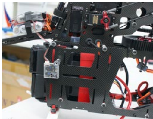
Die RC-Montageplattform nimmt den Pufferakku und den Empfänger auf
