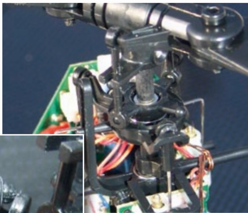
Bewährt: Hinter den Kugelgelenken an den Anlenkpunkten des Taumelscheiben-Außenrings sitzen winzige O-Ringe, um einen Gegendruck aufzubauen und Spiel herauszunehmen. Die Rotorstänge sind geringfügig größer als beim mCP X
