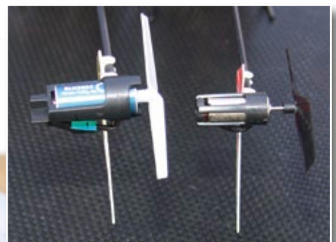
Größenvergleich der Heckmotoren. Links die BL-Version, daneben der Brush-mCP X. Der Durchmesser der Luftschrauben ist identisch
