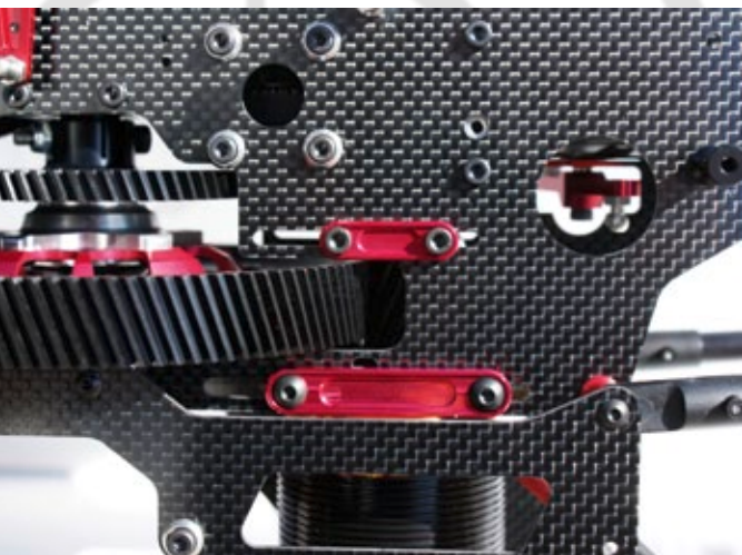
Blick auf die Motorbefestigung und das schrägverzahnte Hauptgetriebe
