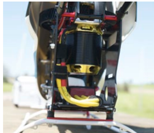
Blick auf den hinten im Chassis sitzenden Scorpion-Außenläufer, der mit einer Ritzelabstützung versehen ist
