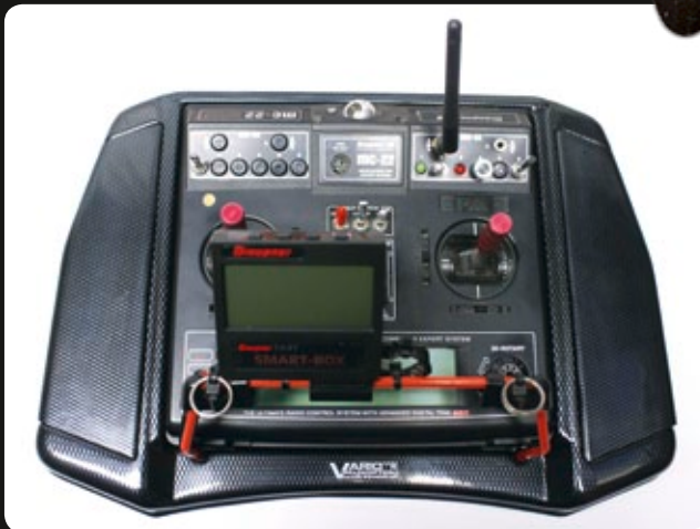
Der fertig umgerüstete Sender. Zwischen 35 Megahertz und HoTT kann bequem mit dem unterhalb der HoTT-Stummelantenne liegenden Schalter gewählt werden. Die Smart-Box ist am Bügel befestigt
