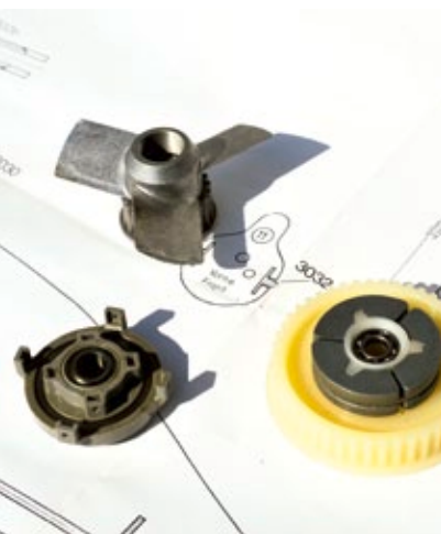
Taumscheibe, das Hauptzahnrad mit integrierter Kupplung sowie der Lüfter mit Antriebszahnrad, das auf den Verbrennermotor geschraubt wurde. Der KAVAN Jet Ranger hatte seinerzeit bereits in der ersten Getriebestufe einen Zahnriemenantrieb
