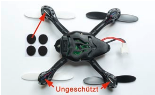
Die serienmäßig offenen Motorzugänge lassen sich einfach mit handelsüblichen Filzgleitern schließen
