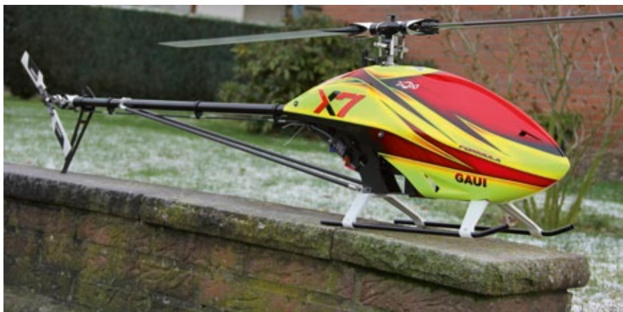
Als Testträger für den Kosmik kam unter anderem auch ein Gaudi X7 zum Einsatz, wobei der Controller bequem am linken Chassisteil befestigt werden konnte
