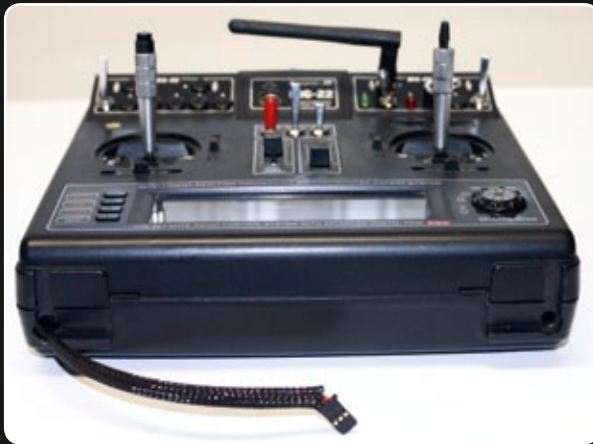
Das Datenkabel für die Smart-Box wird durch das auf 10 Millimeter aufgebohrte Loch für die Haltebügel nach außen geführt
