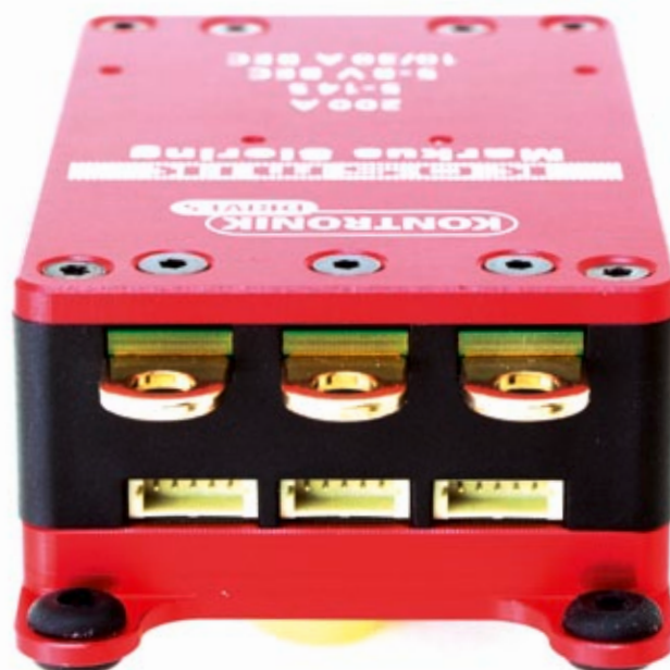
Bei den Motoranschlüssen sind vergoldete Kupferlaschen verbaut, an die man die benötigten Kabel mit Kabelschuhen anschrauben kann
