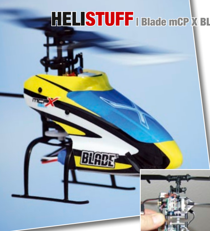
Der Heckausleger des BL (oben) wurden gegenüber dem Brush-mCP X um 19 Millimeter verlängert
