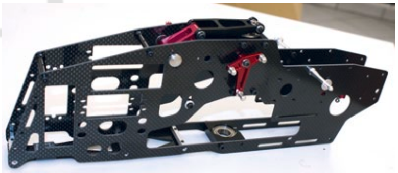
Das obere Chassis, fertig bestückt mit Nickwippe und Rollhebeln
