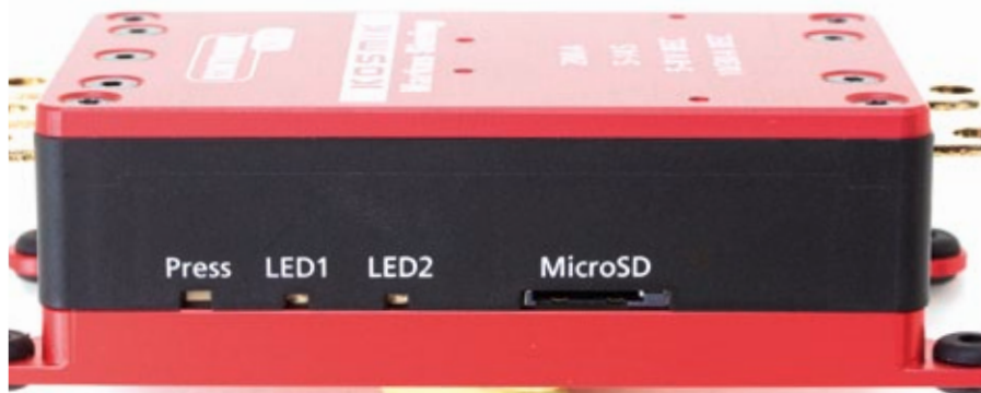
Ganz links der Programmier-Taster, daneben die LED der Modus- und Status-Anzeige. Rechts befindet sich das Einschubfach für die Micro-SD-Karte zum Datenloggen
