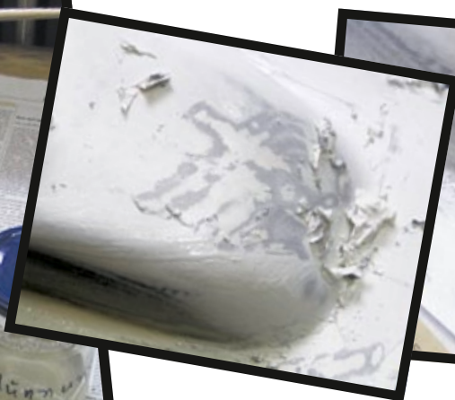
Das beschriebene Abbeizen des Rumpfedekels mit seinen zwei Grundierschichten
