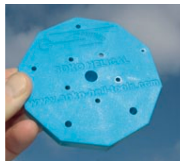
Das Helical ist eine Montageplattform zur Aufnahme des Winkelmessgeräts. Fünf unterschiedliche Randstärken des Zehnecks und definiert angebrachte Befestigungsbohrungen sorgen dafür, dass man es in alle gängigen Blatthalter montieren kann
