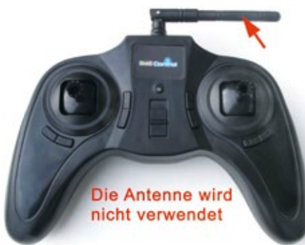
Ein Antennenstummel ist zwar vorhanden, hat jedoch keine Funktion
