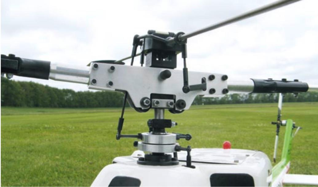
Der Standard-Hauptrotorkopf des Bell 212 Twin Jet, der mit kollektiver Blattverstellung ausgestattet ist. Markant sind der Konuswinkel („V-Form“) sowie die langgestreckten Blatthälse
