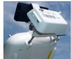
Der Reichweitenverstärker fürs WiFi wird am Tragebügel montiert
