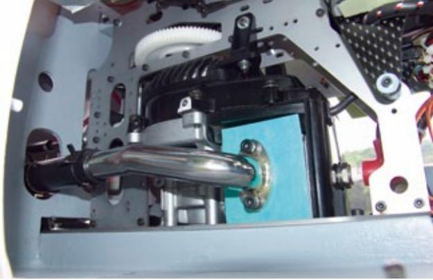
Die Abgasführung mittels Stahlkrümmer und Edelstahl-Schalldämpfersystem von Harald Zimmermann
