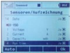
Telemetrie: Die Rubrik Sensoren/Aufzeichnung erkennt angeschlossene Sensoren. Der Nutzer kann festlegen, ob einzelne Werte zusätzlich auf der Speicherkarte abgelegt werden
