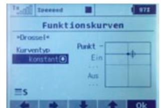
Alle Ausgänge können mit unterschiedlichen Kurven (3 bis 9 Punkte) hinterlegt werden. Bei der geeigneten Motor-Kurve bietet sich bei einem E-Heli mit Governor eine konstante Gerade an
