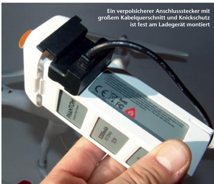
Ein verpolsterter Anschlussstecker mit großem Kabelquerschnitt und Knickschutz ist fest am Ladegerät montiert
