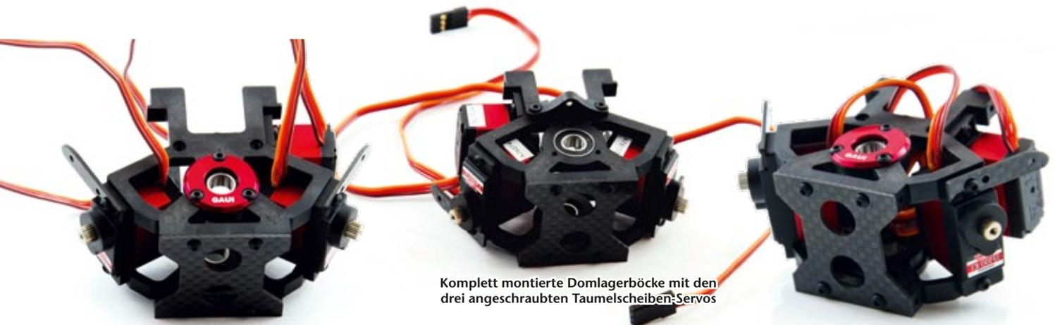
Komplett montierte Domlagerböcke mit den drei angeschraubten Taumelscheiben-Servos
