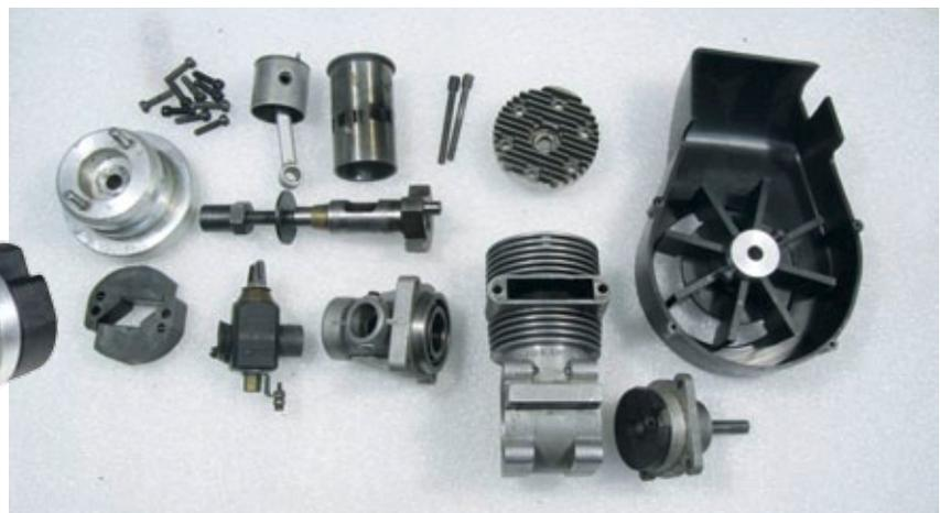
Der alte Methanolmotor HB 61 Stamo samt montiertem Radial-Gebläse und Lüftergehäuse wurde aus der Mechanik entfernt, um Platz für den Elektroantrieb zu schaffen
