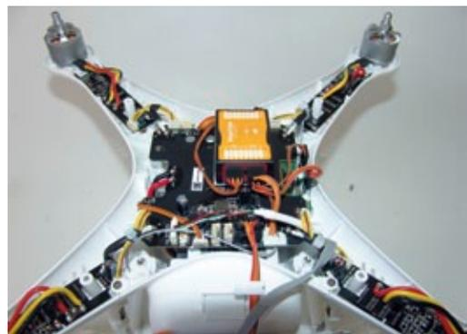
Sauber aufgeräumte, hochwertige Technik innerhalb des Vision. Das Naza-M ist auf der kompakten Zentralplatine befestigt. Das GPS-Modul sitzt im Gehäusedeckel
