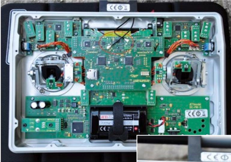
Hier sitzt alles aufgeräumt an seinem Platz. Gut zu erkennen sind die beiden Antennenanschlüsse für die getrennt arbeitenden HF-Module
