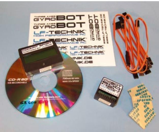
Das Gyrobot 600 Heli-Bundle enthält neben dem Gyrobot und der Cockpit Sport-Programmierbox alle zum Einbau notwendigen Teile wie Klebepads und Anschlusskabel (100 Millimeter Länge)
