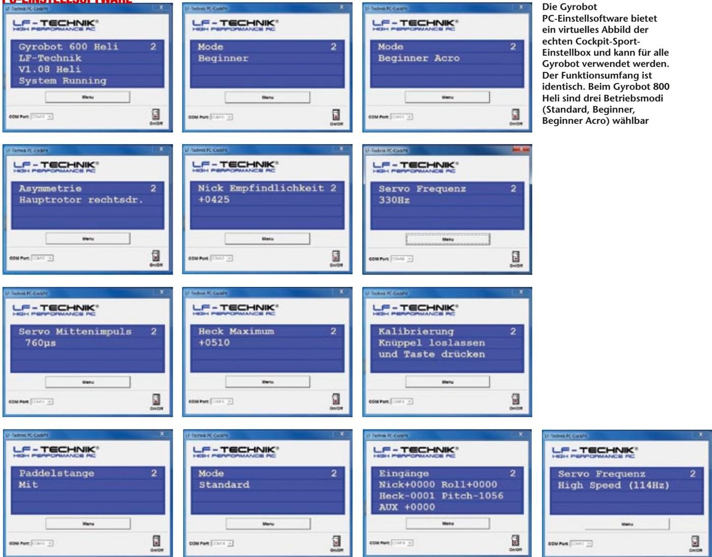
Die Gyrobot PC-Einstellsoftware bietet ein virtuelles Abbild der echten Cockpit-Sport-Einstellbox und kann für alle Gyrobot verwendet werden. Der Funktionsumfang ist identisch. Beim Gyrobot 800 Heli sind drei Betriebsmodi (Standard, Beginner, Beginner Acro) wählbar
