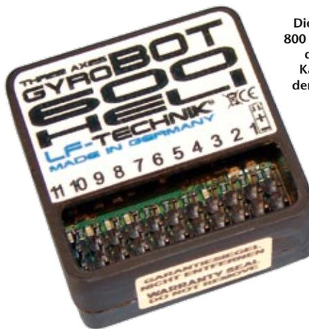
Die Hardware von Gyrobot 600 Heli und 800 Heli mit dem Kunststoff-Gehäuse und den senkrecht nach oben abgehenden Kabel ist identisch, die Firmware macht den Unterschied (600 Heli: nur Standard Mode: 800 Heli: Standard, Beginner, Beginner-Acro Mode)
