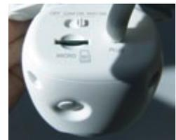
An der Rückseite befinden sich der Schacht für die Micro-SD-Card sowie der Ein-Aus-Schalter (auch für WiFi). Die Stromversorgung erfolgt über den Bordakku
