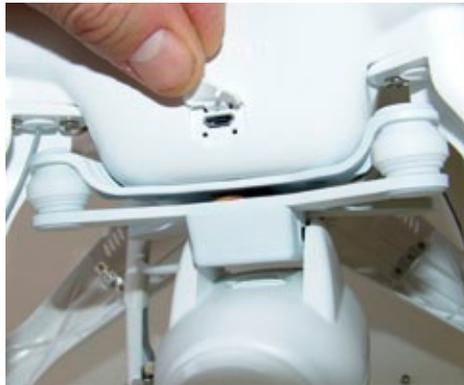
Die bequem von außen zugängliche USB-Buchse, über die die Verbindung mit dem PC hergestellt werden kann. Gut zu erkennen ist auch die gedämpfte Kamerahalterung
