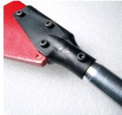
Der verstärkte Blatthalter mit zusätzlich angebrachter Querschraube zur Sicherung. Die Hauptrotorblätter wurden mit jeweils drei Schrauben in der Blattkausche montiert
