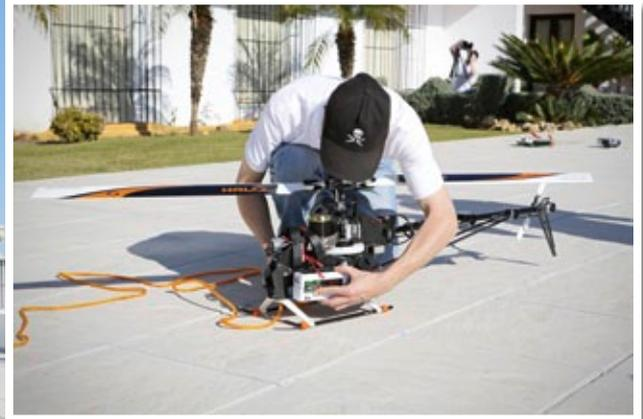
**Startvorbereitung:** Rund zehn Minuten dauert es, die zwei Hochleistungs-Hubschrauber startklar zu machen. Dabei gilt das Vier-Augen-Prinzip: Erst wenn zwei Piloten eine Maschine freigeben, darf sie starten
