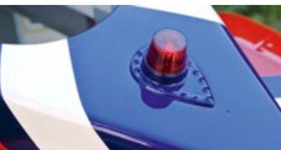
Eines der beiden roten Anti-Collision-Light (Luxeon Emitter)
