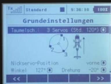
Bei den „Grundeinstellungen“ kann neben Taumelscheibentyp und Anzahl der Servos auch gleich deren Position bestimmt werden. Mögliche Drehung und der Winkel runden die Seite ab
