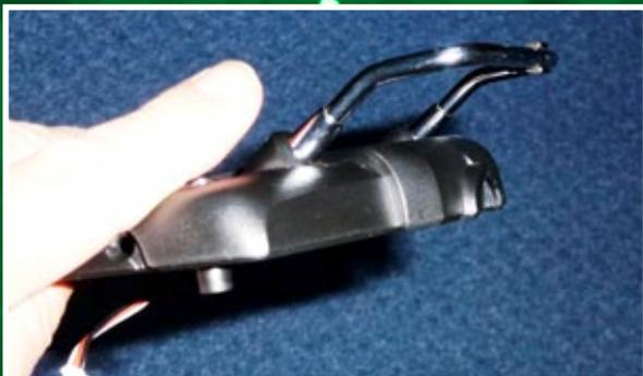
Ist die Bauhöhe des Sendergehäuses für den Koffer zu hoch, lässt sie sich durch umgedrehtes Montieren des Tragegriffs umgedenken
