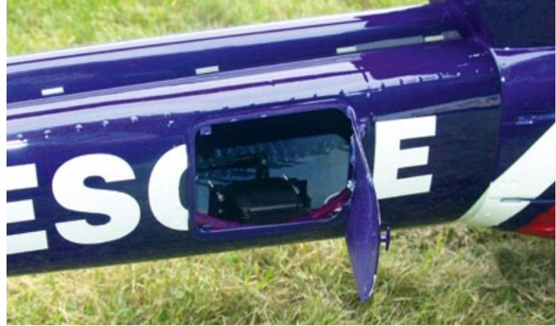
Wartungsklappe am Heckausleger, hinter der das Heckrotorservo untergebracht ist
