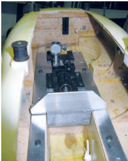
Anpassen des Motorträgers, der aus einem Winkelprofil gefertigt ist
