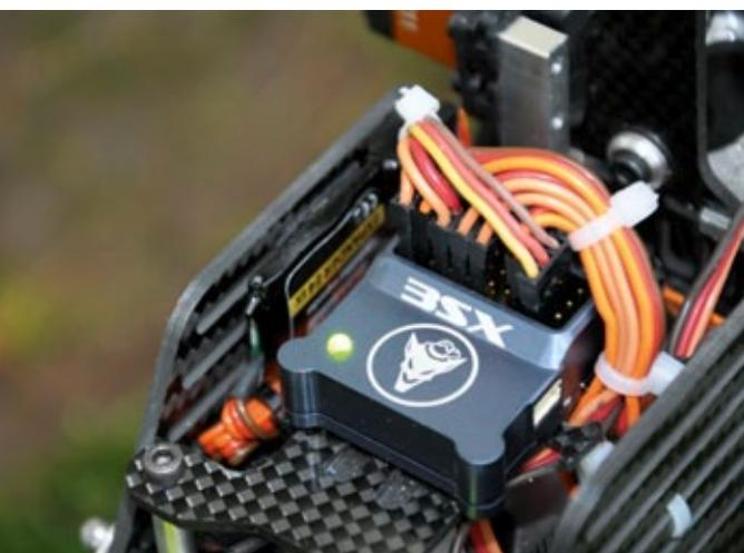
Links neben dem 35X der extrem kleine Vierfach-Expander zum Anschluss von insgesamt vier Sensoren
