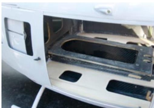
Die verstärkte Bodenplatte zur Aufnahme der Vario-Benzinmechanik
