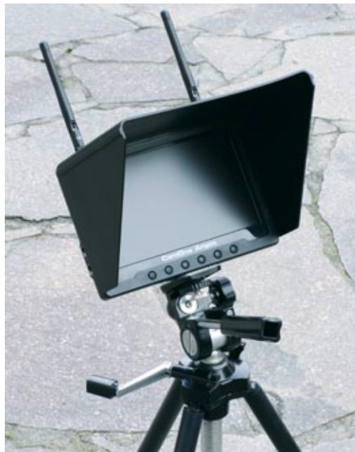
Handgriffen am Sender der Fernsteuerung oder auf einem Fotostativ montiert ist. Kein einziges Kabel ist erforderlich, kein Gefummel mit Dippschaltern. Dank Overscan gibt es auch bei 4:3-FPV-Sendern mit 16:9 Kameras ein ordentliches Bild – und das auf allen legalen 5,8-Gigahertz-Bändern. Wer will da noch meckern? ■
