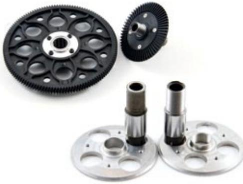
Rechts die dem Baukasten beiliegende, verbesserte Freilaufhülse mit Feingwinde
