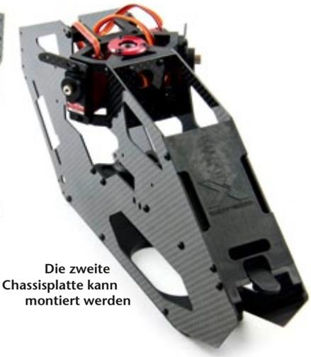
Die zweite Chassisplatte kann montiert werden
