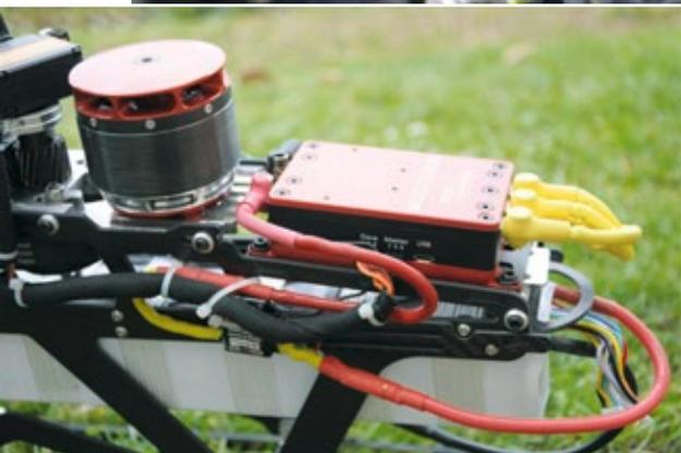
Der in die Zuleitung eingeschleifte Stromsensor MUI 150 – klein, kompakt und sehr präzise. In Zukunft ist geplant, Werte aus dem Kosmik-Controller direkt an die Jeti DC-16 zu übertragen
