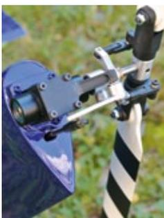
Der Ganzmetall-Heckrotor sitzt scalegerecht auf der rechten Seite. Der Antrieb erfolgt über Starrwelle in Verbindung mit einem Winkelgetriebe
