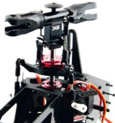
Der fertig montierte Hauptrotormast
