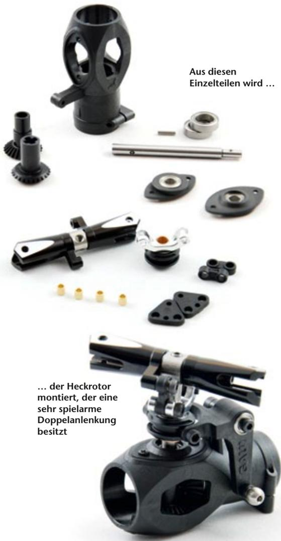
... der Heckrotor montiert, der eine sehr spielerne Doppelanlenkung besitzt
