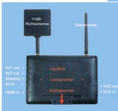
Rückseite der CameOne. Die Kombination mit einer Richtantenne kann sinnvoll sein
