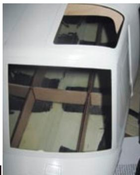
Die Spanten sind bereits eingepasst
