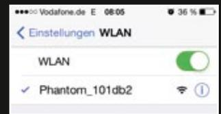
Um eine Verbindung mit der Kamera des Phantom aufzubauen, muss im Smartphone das entsprechende WiFi-Netz gewählt werden
