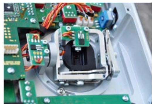
Präzision Made by Jeti – die kugellagerten und komplett aus Metall gefertigten Knüppelaggregate mit Hall-Sensoren. Die Inbusschrauben zeugen von vielfältigen Einstellmöglichkeiten
