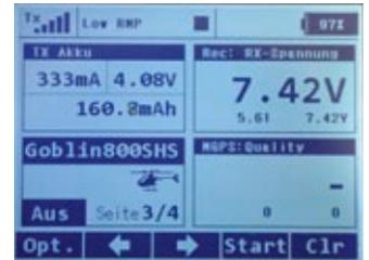
Empfänger- und Senderspannung sind Werte, die auch ohne zusätzliche Sensoren immer übermittelt werden. Ab Firmware 2.2 bekommen wir auch noch Informationen über die aktuelle Empfangsqualität der beiden HF-Module
