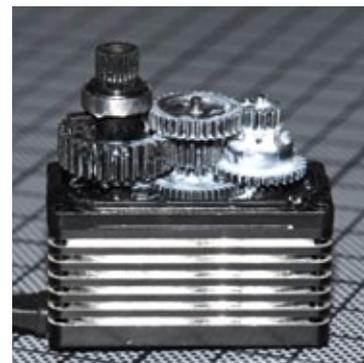
Auch beim neuen HS-8315BH ist das Servogehäuse-Mittelstück mit den Kühlrippen aus dem Vollen gefräst. Zur Erhöhung der Lastfestigkeit ist der Servodeckel mit zwei zusätzlichen Verschraubungen mit dem Mittelstück verbunden (Bild ganz oben)
