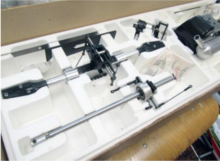
Blick in den Original Graupner-Mechanik-Baukasten der Bell 212, wie er 1973 ausgeliefert wurde. Viele Teile waren bereits serienmäßig vormontiert
