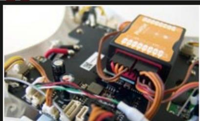
Ist ausreichender GPS-Empfang gegeben, sorgt ein ausgeklügeltes Sicherheitssystem bei Signalausfall oder bei niedriger Spannung für automatisches Landen – natürlich auch beim Phantom 2 Vision. Die Kombination mit allen markt gängigen PPM-Empfängern ist möglich, ebenso wird das Futaba-S-Bus-Signal unterstützt. Über die integrierte USB-Schnittstelle können Updates aufgespielt und die Verbindung mit dem Computer zwecks Einstellungen vorgenommen werden. Das gilt auch für den Phantom-Sender.
