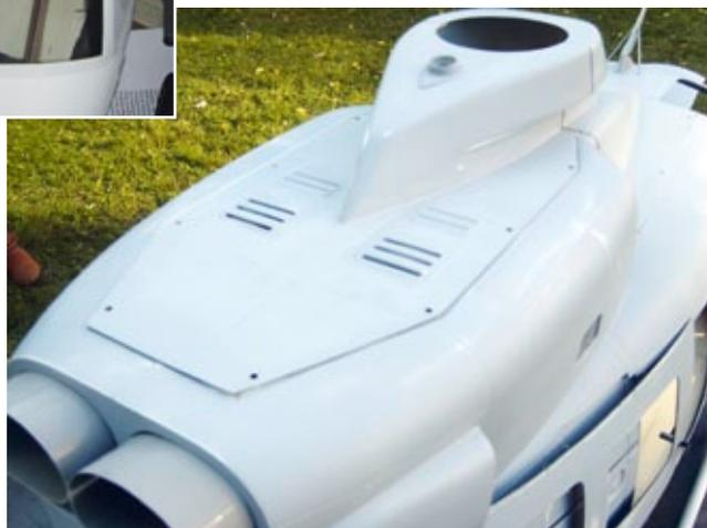
Die Abdeckhaube mit ausgearbeiteten Lüftungsschlitzen
