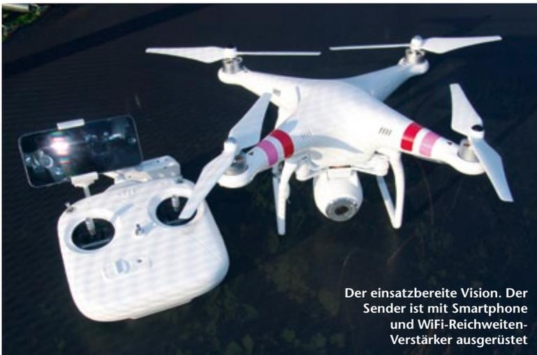
Der einsatzbereite Vision. Der Sender ist mit Smartphone und WiFi-Reichweitenverstärker ausgerüstet
