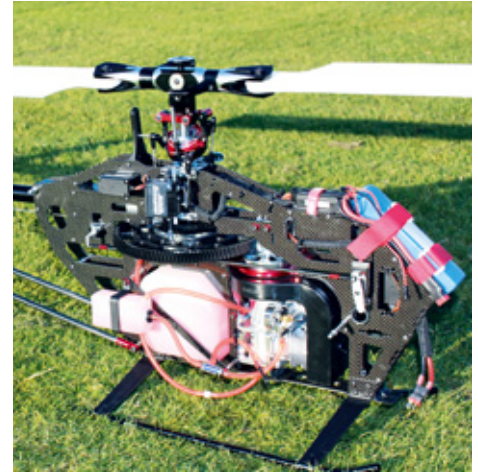
Das Heckrotorservo befindet sich vorne im Chassis. Unter dem Nickservo sitzt in Höhe des Hauptzahnrad der Heckgestänge-Umlenkhebel, der für eine geradlinige Gestängeführung sorgt
