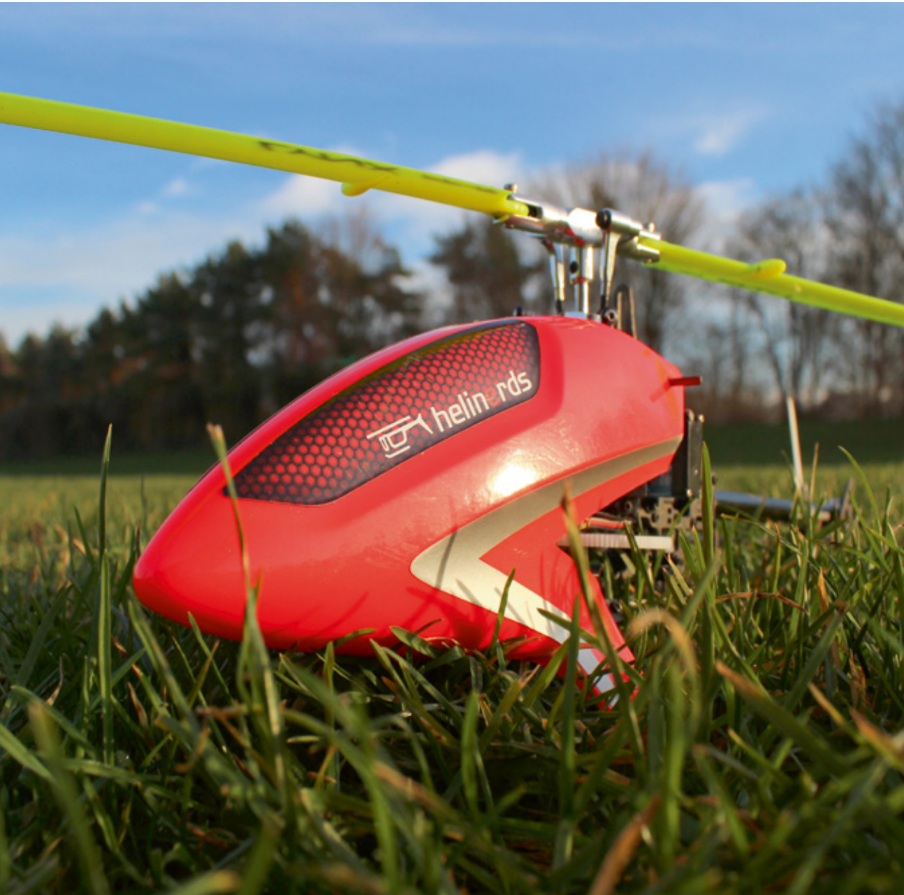
Die leuchtfarbene Kabinenhaube ist auch in der Luft gut zu erkennen und besitzt im Bereich der Kufenstreben angeformte „Flügel“
