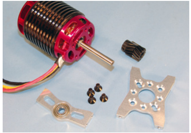
Er wird mit der Lagerplatte verschraubt, die Welle ist mit einem Gegenlager abgestützt
