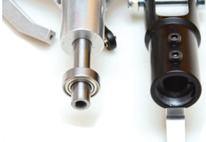
Die Blattlagerwellen des Dreiblatts sind ohne Dämpfungselemente ausgeführt
