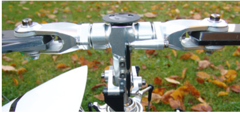
Die Anlenkgeometrie des V.2 (ohne Lage-Rücksteuerung der Blattebene) im Vergleich zum V.1 (rechts) mit geringer Rücksteuerung
