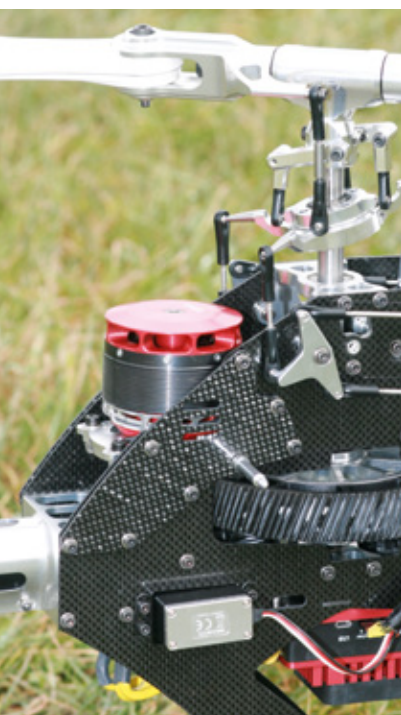
Deutlich zu erkennen ist die Chassis-CFK-Aufdoppelung im Bereich des Motors, ebenfalls das darunter befindliche Heckrotorservo
