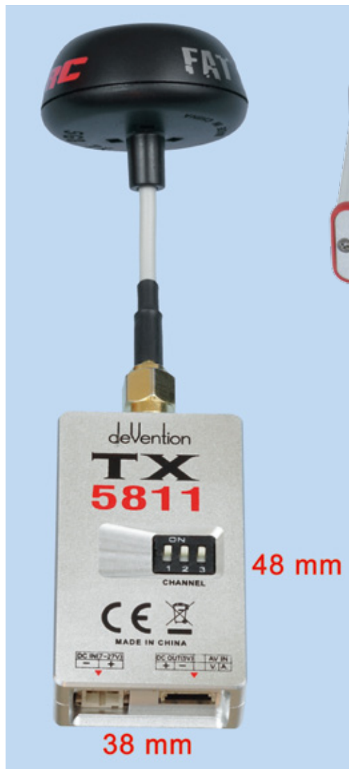
Beispiel für einen legalen 25mW Sender im B-Band, sauber in ein Gehäuse eingebaut. Die mitgelieferte Antenne ist linksdrehend, die hier abgebildete Fremdantenne rechtsdrehend
