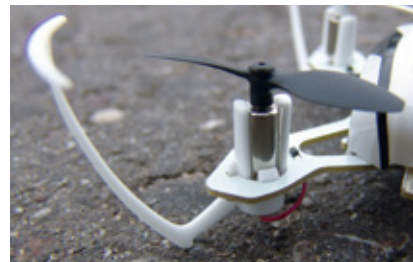
Die winzigen Props werden durch seitliche „Spinnenbeine“ geschützt
