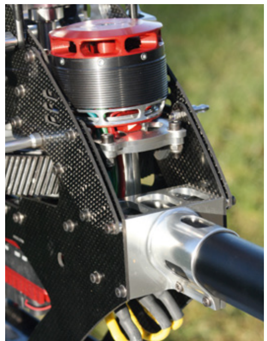
Der Pyro 800 ist mit einer Platte verschraubt, die wiederum einstellbar auf dem Flansch des mittleren Rotorwellenlagers sitzt. Auch deutlich zu erkennen: die Tropfenprofilform des Heckrohrs
