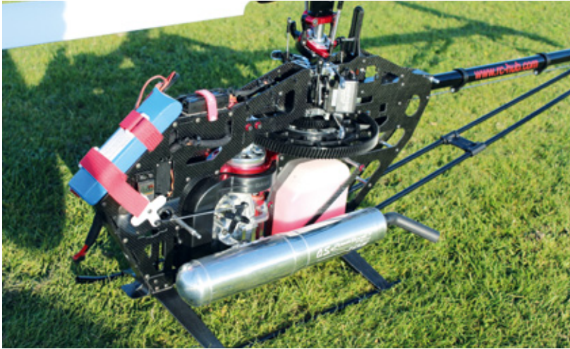
Unmittelbar hinter dem 2s-Empfängerakku befindet sich die Graupner Flybarless-/Empfänger-Einheit GR-18 3xG FBL, darunter das Gasservo. Der Schalldämpfer passt sich harmonisch in die Konstruktion ein
