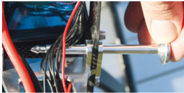
Die mit einem Verriegelungsbolzen fixierte Akkuplatte
