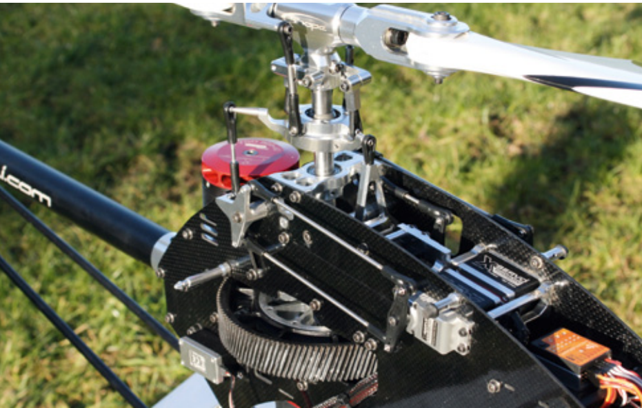
Vor den beiden Roll-Taumelscheibenservos sitzt das microbeast-Flybarless-System. Dadurch ergeben sich kurze Wege bei der Verkabelung
