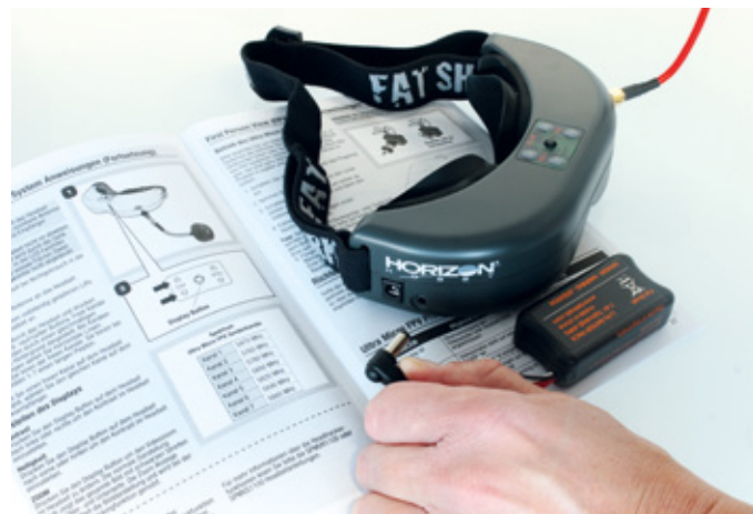
Die Anleitung erklärt exakt, was wie zusammenzustecken ist, beispielsweise darf der Akku erst angeschlossen werden, wenn die Antenne montiert ist
