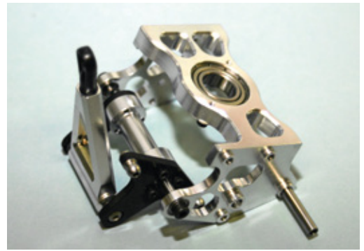
Ganz oben im Bild die mittlere Rotorwellen-Lagerung, auf der rechts der Motorträger verschraubt wird. Dadurch ergibt sich eine sehr steife Verbindung zwischen Rotor- und Motorwelle. Der kleine Lagerbock ist die untere, dritte Rotorwellenlager
