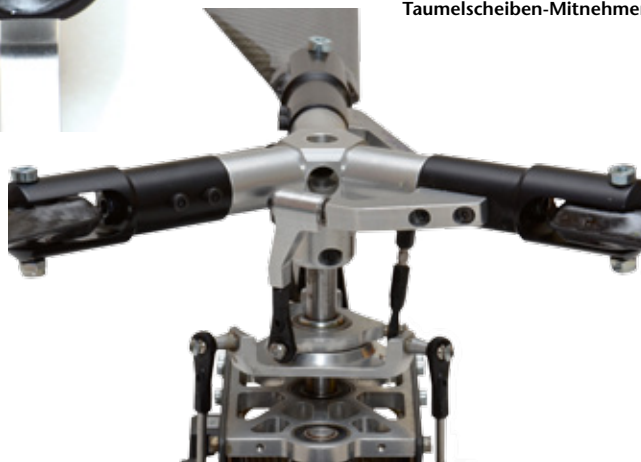
Der montierte Triabolo-Rotorkopf mit doppelt kugelgelagertem Alu-Arm als Taumelscheiben-Mitnehmer
