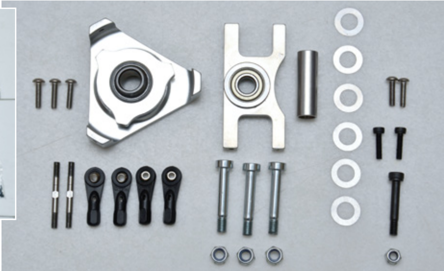
Lieferumfang des Triabolo-Umbausatzes. Neben dem Hauptrotor und den Blättern liegen auch eine neue Taumelscheibe und ein Stützlager (optional) bei
