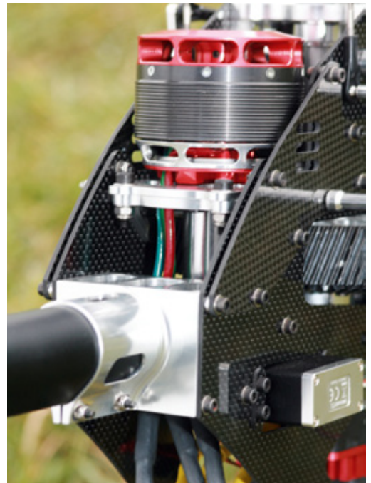
Aufgeräumt: Sämtliche Kabel lassen sich mühelos innerhalb des Chassis sauber verlegen
