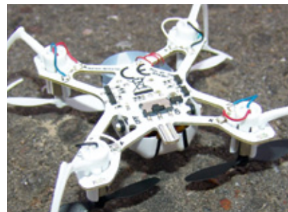
Die Unterseite der Zentralplatine, auf der alles untergebracht ist. Deutlich zu erkennen – der winzige Ein-aus-Schalter. Der am Mittelteil herausstehende Zapfen ist der Ladeanschluss
