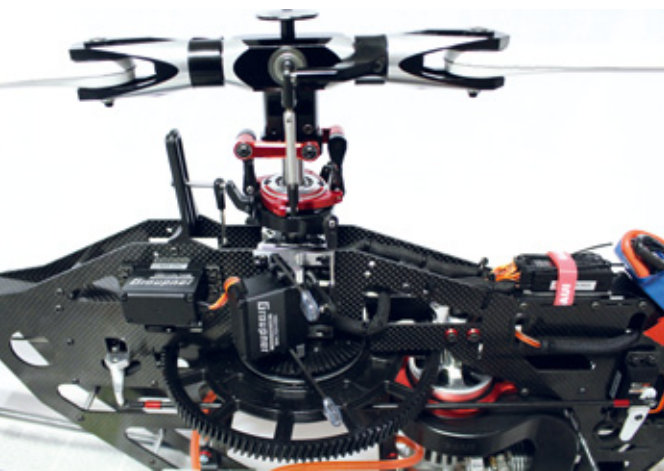
Die beiden Rollservos mit ihren anmontierten CFK-Hauben-Abstandshaltern sind stehend an den Rotorwellen-Lagerböcken befestigt, das Nickservo liegt unter der Taumelscheiben-Führung
