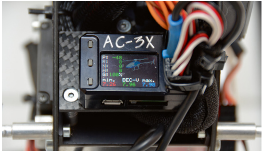
Das eingebaute, neue Plöchinger-Stabilisierungssystem AC3X-V3 mit Farb-Display
