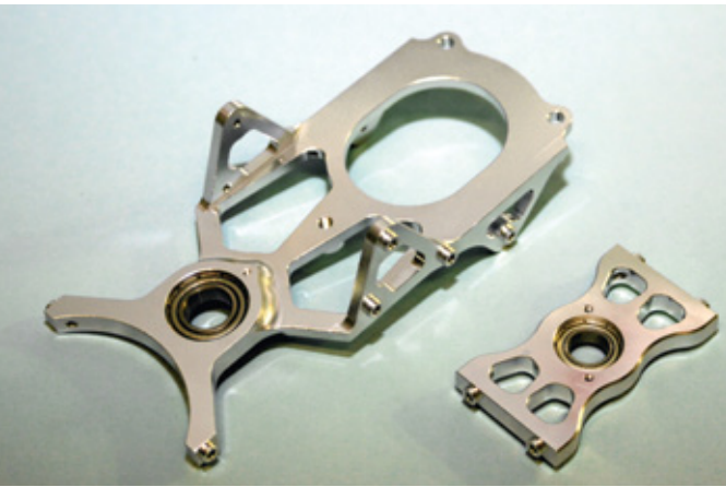
Ganz oben im Bild die mittlere Rotorwellen-Lagerung, auf der rechts der Motorträger verschraubt wird. Dadurch ergibt sich eine sehr steife Verbindung zwischen Rotor- und Motorwelle. Der kleine Lagerbock ist die untere, dritte Rotorwellenlager
