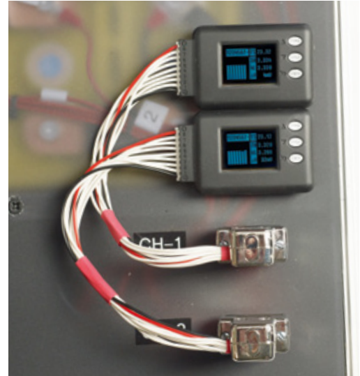
Spannung immer im Blick: Der CellLog 8s von Junsu ist mit seinem Balkendiagramm der Einzelzellen-Spannungen sehr übersichtlich
