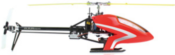
Die leuchtfarbene Kabinenhaube ist auch in der Luft gut zu erkennen und besitzt im Bereich der Kufenstreben angeformte „Flügel“
