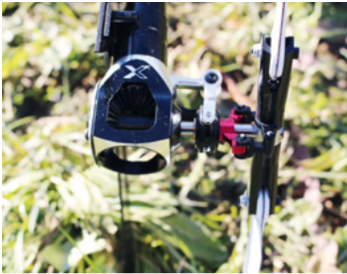
Bestens geschützt können die Heckrotor-Kegelräder ihren Dienst verrichten. Dank der Scheren-Anlenkung ist die Heckrotor-Steuerung sehr spielarm. Sehr elegant sind auch die schlanken Blatthalter konstruiert
