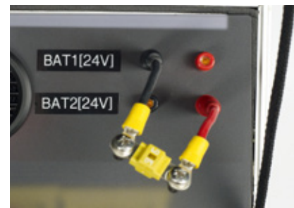
Zur Sicherheit wurde beim 48-Volt-Betrieb im Verbindungsstecker eine zusätzliche KFZ-Sicherung (50 V/60 A) berücksichtigt
