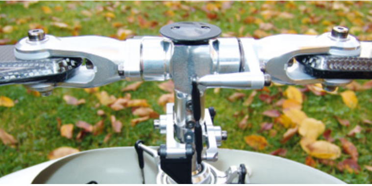
Die Anlenkgeometrie des V.2 (ohne Lage-Rücksteuerung der Blattebene) im Vergleich zum V.1 (rechts) mit geringer Rücksteuerung
