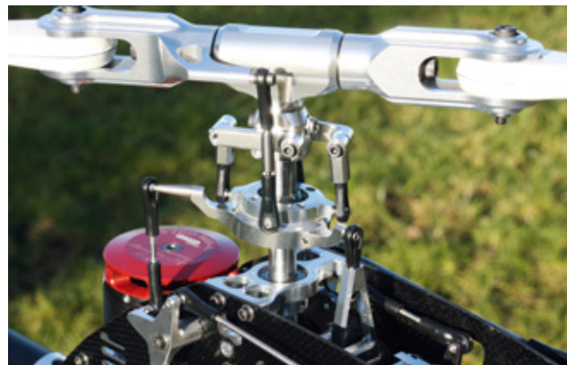
Die Anlenkgestänge haben Rechts-/Links-Gewinde, sodass man den Spurlauf ohne Abbau der Gestänge einstellen kann. Die Blatthalter sind einteilig, die Mitnehmer-Hebel werden direkt am Zentralstück verschraubt
