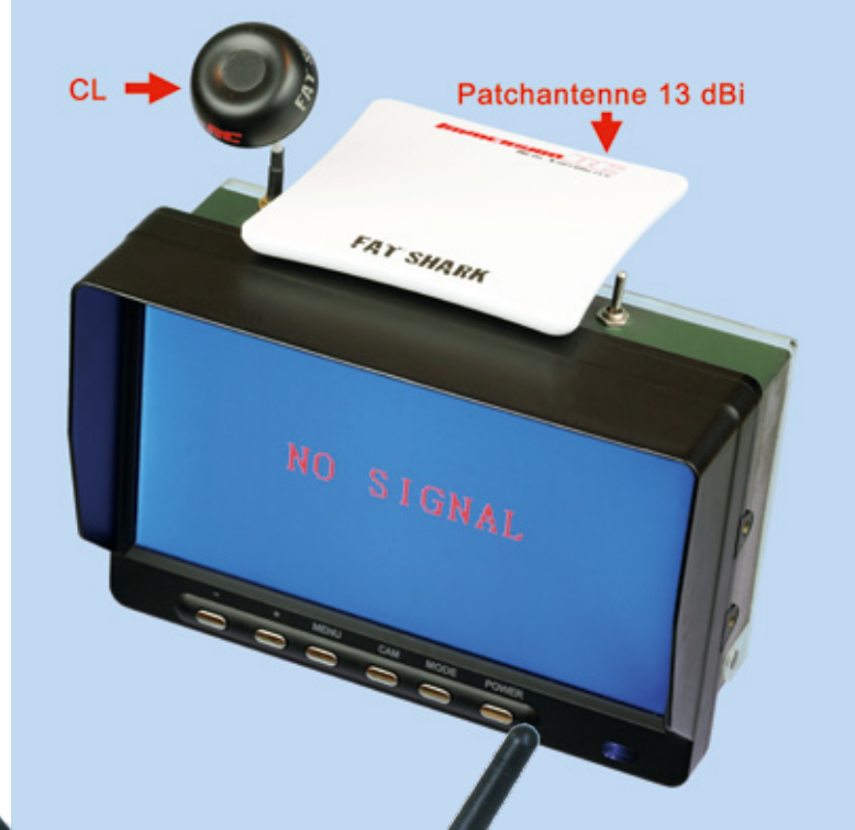
Beispiel für die Nutzung mit zirkular polarisierter Richtantenne und Rundantenne. Das System für den Notfall, wenn hohe Reichweite gefragt ist
