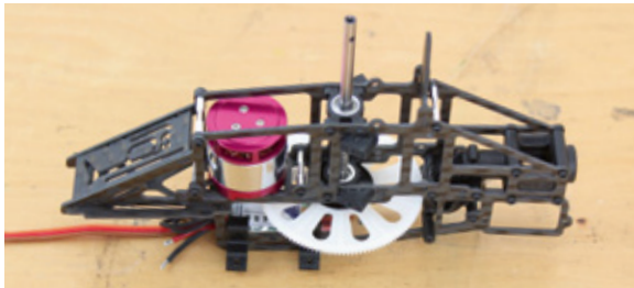
Motor, Getriebe und Controller sind montiert
