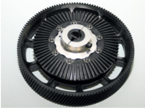
Das 22 Millimeter hohe, schrägverzahnte Hauptzahnrad mit Modul 1. Das Tellerrad dient als Heckantrieb. Der Freilauf läuft nicht direkt auf der Rotorwelle, sondern auf einer gehärteten Hülse
