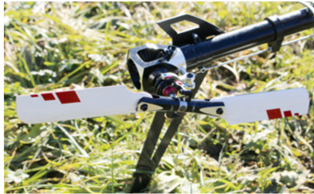
Bestens geschützt können die Heckrotor-Kegelräder ihren Dienst verrichten. Dank der Scheren-Anlenkung ist die Heckrotor-Steuerung sehr spielarm. Sehr elegant sind auch die schlanken Blatthalter konstruiert
