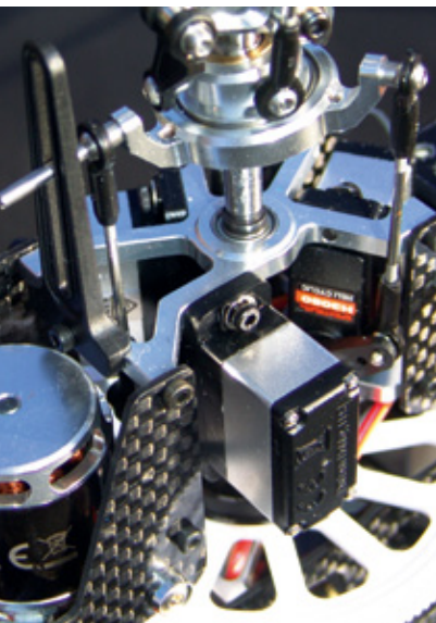
Hat sich bereits in anderen Blade CFX-Versionen bewährt – die senkrechte Anordnung der Taumelscheibenservos, die in zwei sternförmig gefrästen Alu-Lagerplatten montiert sind
