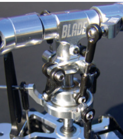
Die Mitnahme des Taumelscheiben-Innenrings erfolgt über kugelgelagerte, am Zentralstück montierte Alu-Arme
