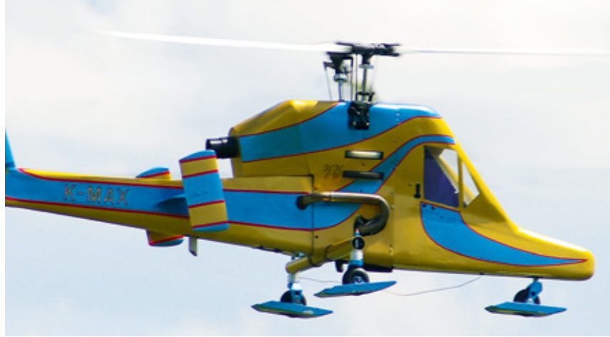
K-MAX-Modell im schnellen horizontalen Vorwärtsflug, sodass die Antriebsleistung bedeutend höher ist als im Schwebeflug. Aus diesem Grund steht das Höhenleitwerk bei etwa +15 Grad Anstellwinkel
