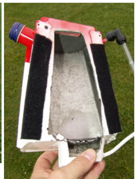
Die Blech-Tankkatrappe mit Füllstützen ist abnehmbar gestaltet, um die LiPos bequem einsetzen zu können
