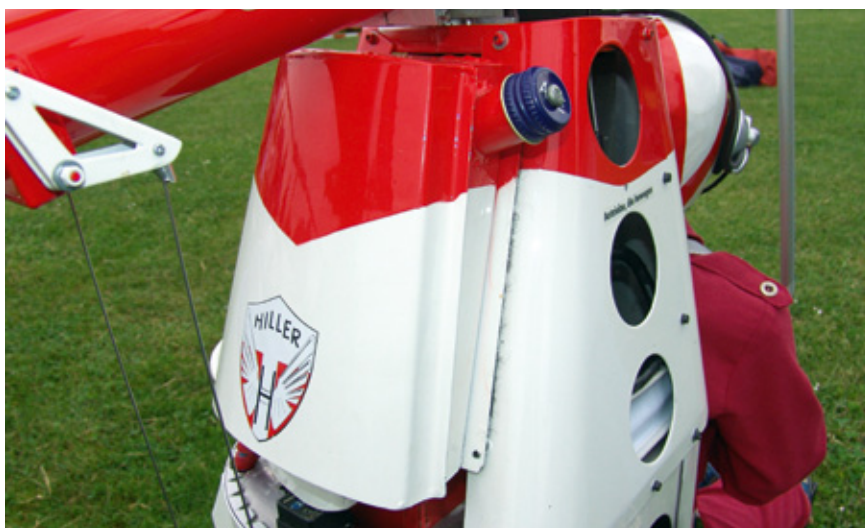
Die Blech-Tankkatrappe mit Füllstützen ist abnehmbar gestaltet, um die LiPos bequem einsetzen zu können
