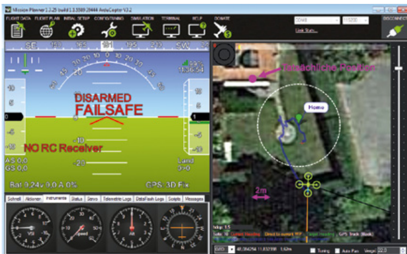
Abbildung 8: Hier wurde Senderausfall simuliert. Nahe Home schaltet der Kopter bei Failsafe nicht auf RTH, sondern auf LAND. Rechts wurde der GPS Glitch getestet. Der Kopter stand ungünstig auf dem Balkon, beim Armieren wurde Home ungenau markiert. Trotz 10 Satelliten und HDOP 1,5 driftete die Position entlang der violetten Linie
