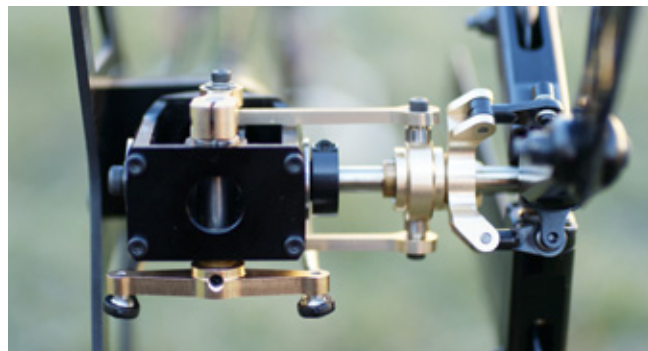
Der Dreiblatt-Heckrotor mit seiner doppelten Führung der Schiebehülse – alles kugelgelagert
