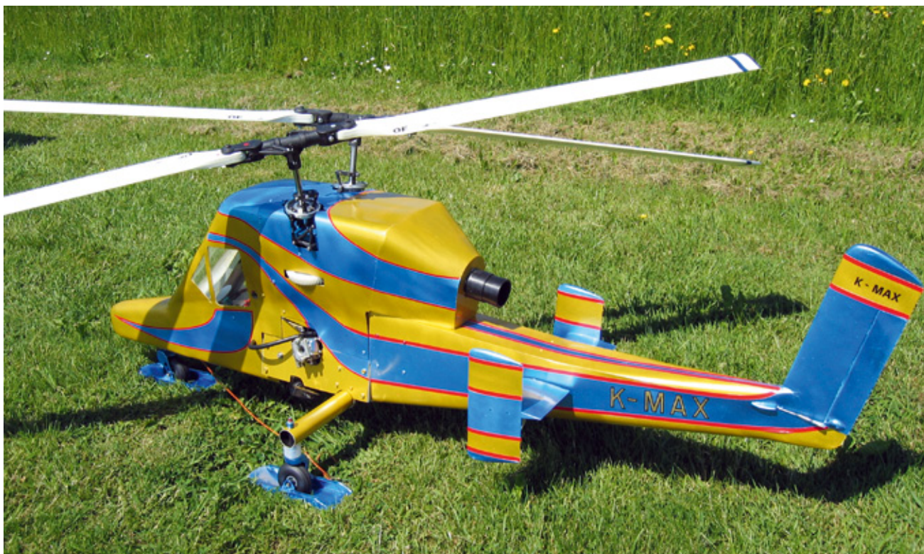
Der Nachbau des Kaman K-MAX des Autors Ernst Wieland im Maßstab 1:7,1. Rotordurchmesser 2 x 1.520 mm, Antrieb über 23er-Benzinmotor und Abfluggewicht 9.500 Gramm
