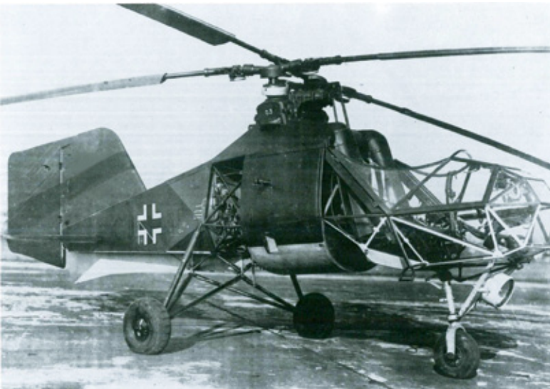
Flettner FI 282 „Kolibri“ aus der Serienfertigung. Auch hier wurden Höhen- und Seitenleitwerke angelenkt, um die aerodynamischen Flettner-Eigenarten steuerungstechnisch in den Griff zu bekommen
