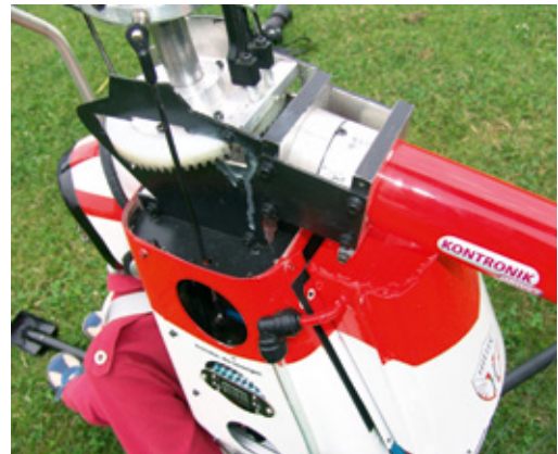
Das Heckrohr ist mit zwei an den Seitenteilen befindlichen Alu-Lagerschalen festgeklemmt. Das Heckrotor-Antriebsritzell greift von unten in den Zahnkranz des Hauptzahnrad ein
