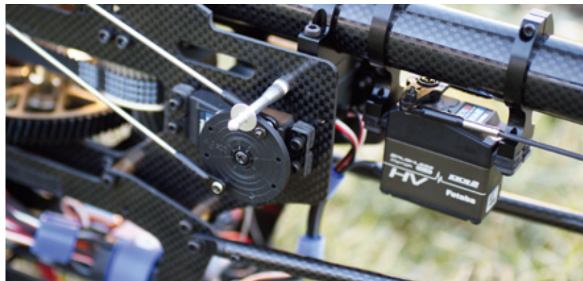
Blick aufs linke Rollservo, die Kabinenhaubenabstützung sowie das mittig unter dem Heckrohr platzierte Heckrotorservo
