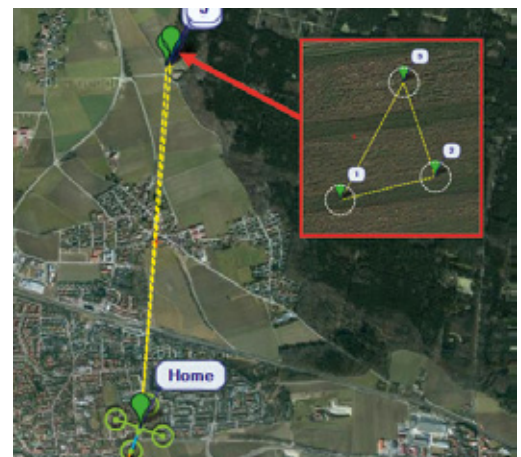
Abbildung 5: Ist eine Route im Kopter gespeichert, führt versehentliches Aktivieren von AUTO zum Wegflug des Kopters, hier aus dem heimatlichen Garten (Home) zum Flugfeld mit unserer Testroute oben im Bild
