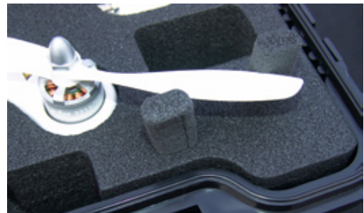
Die Props werden zwischen diesen beiden Schaumstoff-Erhebungen „geparkt“. Deutlich zu erkennen ist auch die umlaufende Dichtung am Rand des Koffers
