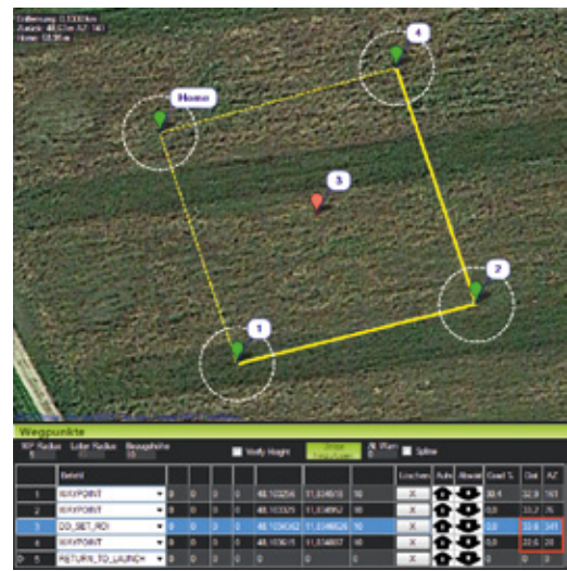
Abbildung 6: Das Einfügen eines ROI-Punktes (Region of Interest) wird im Text beschrieben. Hier wird die Kopternase beim Flug von WP2 nach WP4 auf Punkt 3 ausgerichtet
