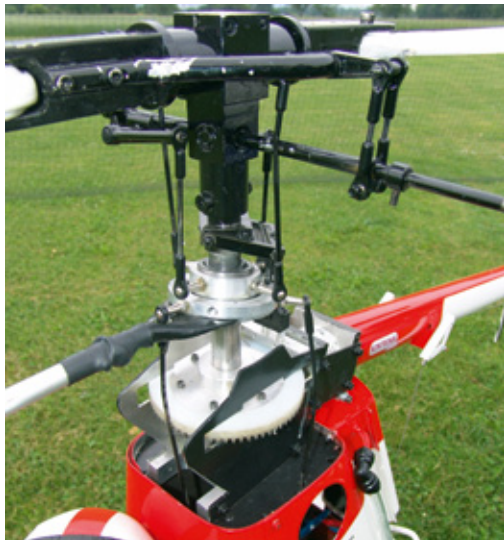
Der Paddel-Hauptrotorkopf eines ausgedienten Jet Ranger wurde kurzerhand für den Einsatz auf der Rotorcycle umfunktioniert. Scale-untypisch ist lediglich die unter den Rotorblättern angeordnete Paddelebene – das bemannte Vorbild hatte diese oberhalb
