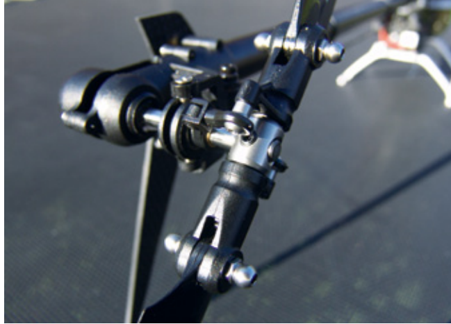
Der via Zahnriemen angetriebene Heckrotor mit Kunststoff-Blatthaltern und Propeller-Momentgewichten. Das CFK-Heckgestänge ist doppelt gelagert
