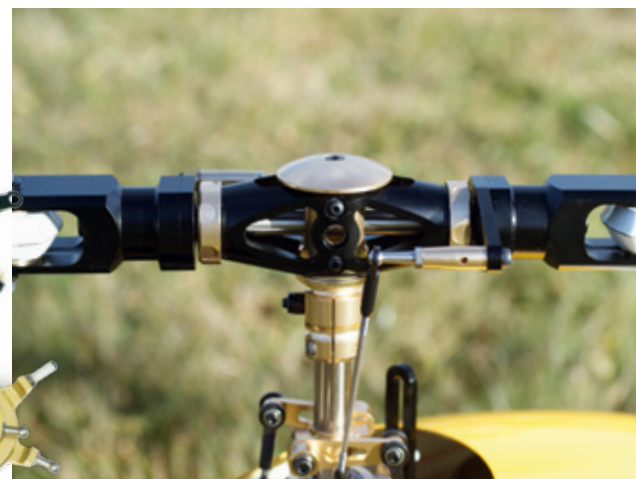
Beim Flybarless-Hauptrotorsystem kann zwischen der Zwei- oder Dreiblatt-Ausführung gewählt werden. Alle Teile sind hochpräzise aus Aluminium gefertigt und schwarz beziehungsweise gold eloxiert
