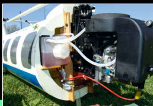
Frontmechanik mit Antriebsmotor und Tank. Deutlich zu erkennen sind die beiden senkrechten, im Rumpf verklebten Spanten, an denen die Mechanik an vier Punkten verschraubt ist
