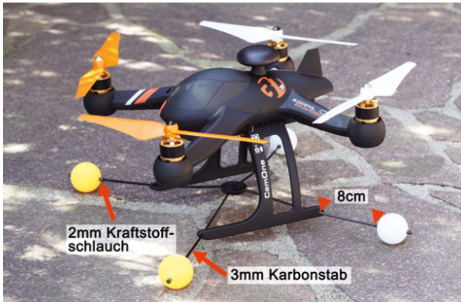
Abbildung 1: Unser Versuchsträger Zoopa Q550 wurde wegen der großen Kippgefahr bei schlechten Bedingungen mit dem in RC-Heli-Action 7/2015 beschriebenen Landegestell (Trade4me 34770) versehen
