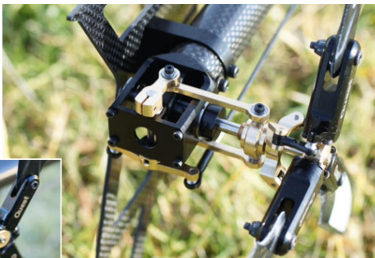
Eines der Highlights ist der über Push-Pull angelenkte Heckrotor. Zwei Gestänge führen nach hinten zum Umlenkhebel
