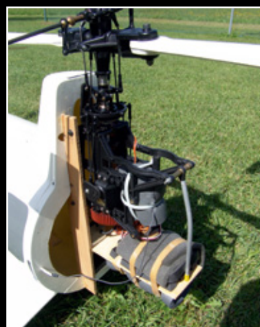
Das gleiche Prinzip mit zwei senkrecht stehenden, mit dem Rumpf verklebten Sperrholzspanten gibt es auch an der hinteren Mechanik. Eine zusätzliche Bodenplatte sitzt zwischen den Spanten und nimmt Bordrechner, Empfänger und weiter vorne die beiden Kreisel auf
