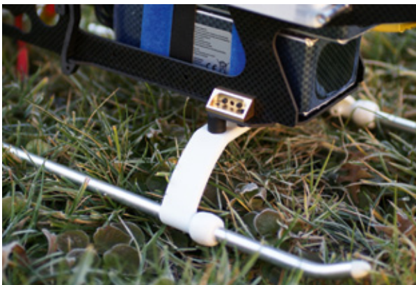
Detail der Kufenbefestigung am Chassis in Verbindung mit Schwingungsdämpfern
