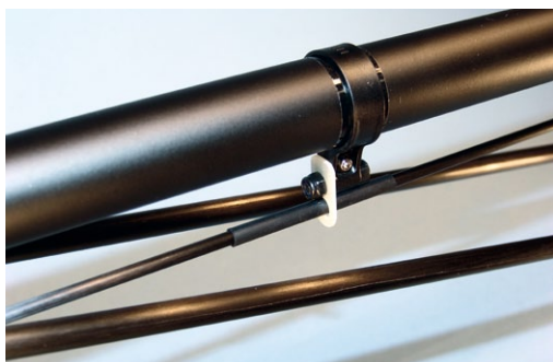
Für die Führungsschelle am Heckrohr beziehungsweise Schubstange wurde eine kleine Verlängerung gebaut. So läuft die CFK-Schubstange ganz ohne Vorspannung
