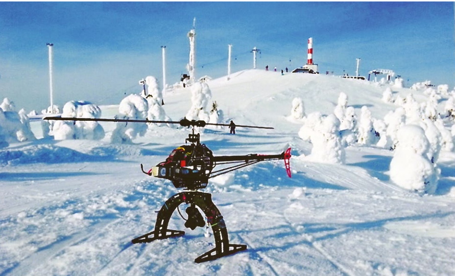
Es wird auch gefilmt, wenn es kalt ist – Erprobungsflüge bei einer Temperatur von minus 15 Grad Celsius, bei der die Technik auch funktionieren muss
