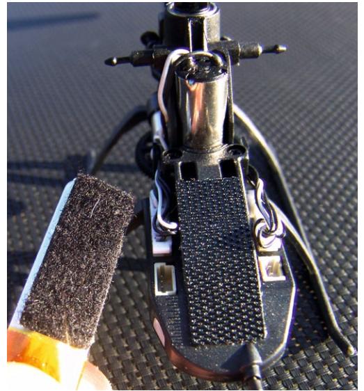
Der LiPo wird mit Klettband auf der Konsole befestigt
