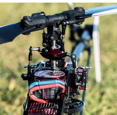
Detail der 120-Grad-Anlenkung der Taumelscheibe
