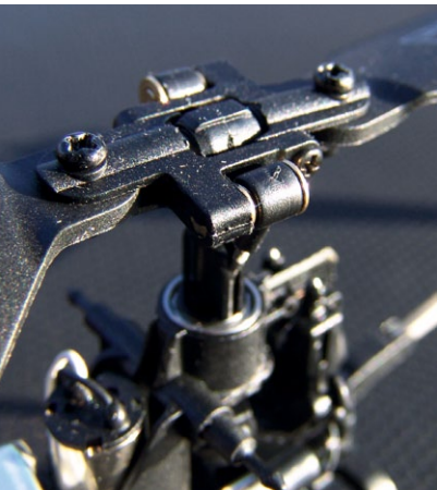
Die Rotorkopf-Wippe des drehzahlgesteuerten FBL-Zweiblatts mit eng anliegenden Rotorkopf-Gestängen
