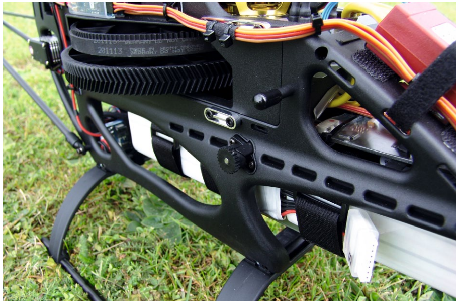
Die einziehbare Akku-Platte wird von zwei federbelasteten Drehschiebern gehalten
