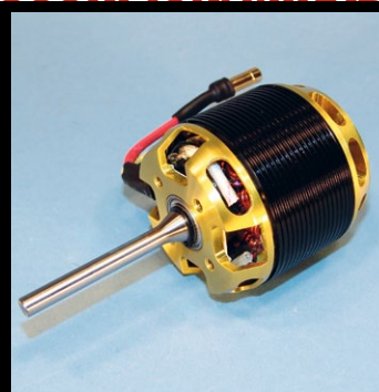
Die Motorwelle des Scorpion HK4525 Ultimate ist mit 55 Millimeter Länge ungewöhnlich lang. Sie ist ab Werk an passender Stelle mit einer Ablachung für das Ritzel versehen
