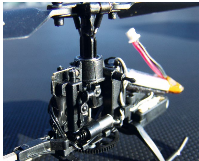
Deutlich zu erkennen sind die eng an der Rotorwelle anliegenden Gestänge
