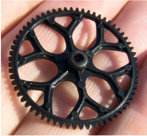
Das Hauptzahnrad der Einbau-Mechanik ist zwar filigran, aber durch die Versteifungsäste sehr robust konstruiert
