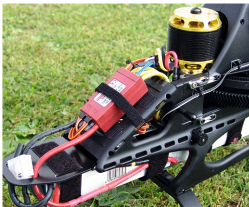
Der JIVE Pro sitzt mit Klettband gehalten auf seinem Podest. Die Anschlusskabel müssen vorne durch die Akku-Platte hindurch nach unten laufen, ansonsten lässt sich die eng anliegende Kabinenhaube nicht überschieben
