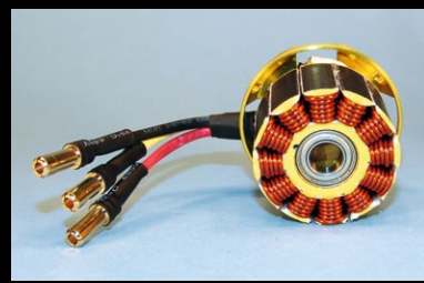
Die Qualität des Motors ist imposant. Seine Eindrahtwicklung wurde perfekt von Hand in die Nuten eingelegt und mit einem Hauch Epoxy zur Fixierung vergossen
