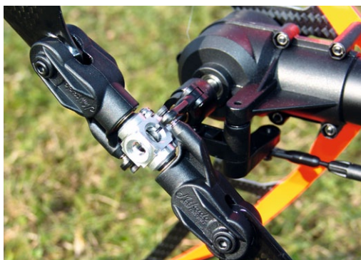
Der Heckrotor verfügt über eine Blattlagerwelle und Dämpfung per O-Ringe im Zentralstück
