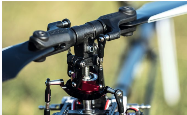
Detail der Rotorkopf-Anlenkung mit den stabilen Gestängen und den konventionellen Mitnehmer-Armen
