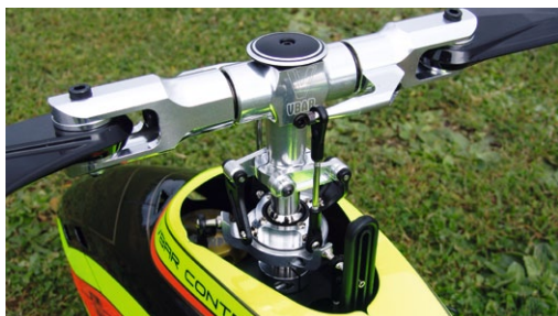
Der Rotorkopf mit seiner massiven Dämpfung der durchgehenden Blattlagerwelle in drei O-Ringen pro Seite. Die Radiallager sind bereits ab Werk in die Blattgriffe eingepresst
