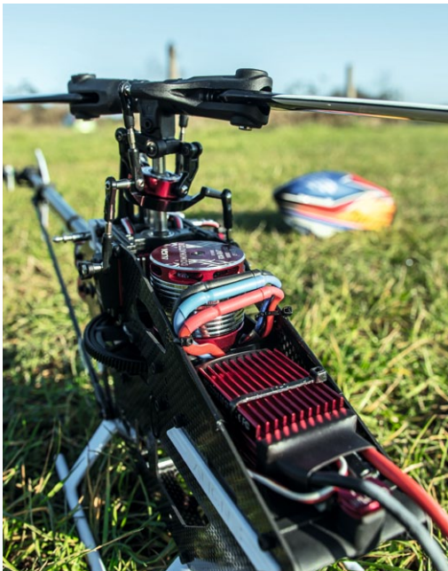
So sind die Verbindungskabel zwischen Motor und Controller am Chassis fixiert
