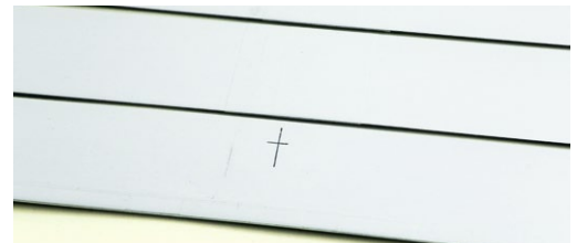
Die Schwerpunkte wurden mit Bleistift auf den Blättern ermittelt und markiert
