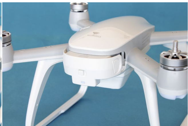
Am Heck ist der großdimensionierte Schacht für den Akku. Die elektrische Verbindung wird hergestellt, sobald man den Energiespender einschiebt
