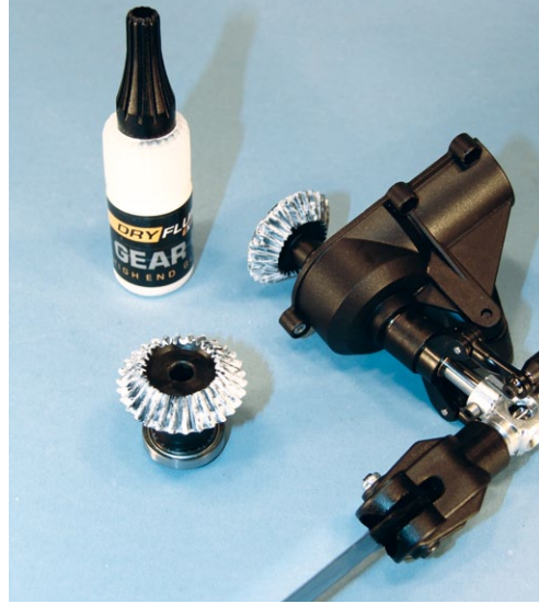
Beim Verbau der Kegelzahnräder wurde der Trockengleitstoff GearLube von Dryfluid verwendet. Dieser Gleitlack trocknet nach dem Auftragen per Pinsel komplett ab, wird deshalb bei schneller Drehung nicht abgeschleudert und reduziert die Reibung
