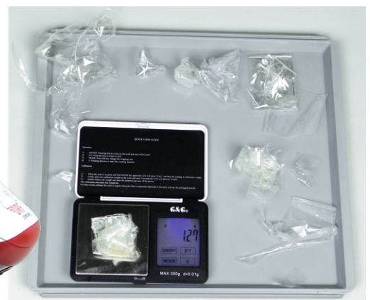
Auch das Gewicht der „Trimm“-Folie muss berücksichtigt werden, da alle Blätter (bei identischer Schwerpunktage) auch gleichschwer sein sollten
