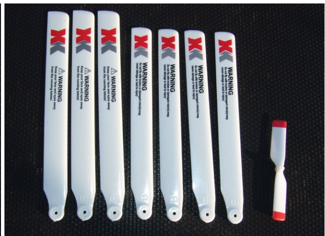
Die schmalen Kunststoff-Hauptrotorblätter des Dreiblatt-Rotors der Ecureuil sind geringfügig (siehe Datenkasten) länger als die des Vierblatt-Rotors (EC 145). Der Heck-Prop ist bei beiden Modellen identisch
