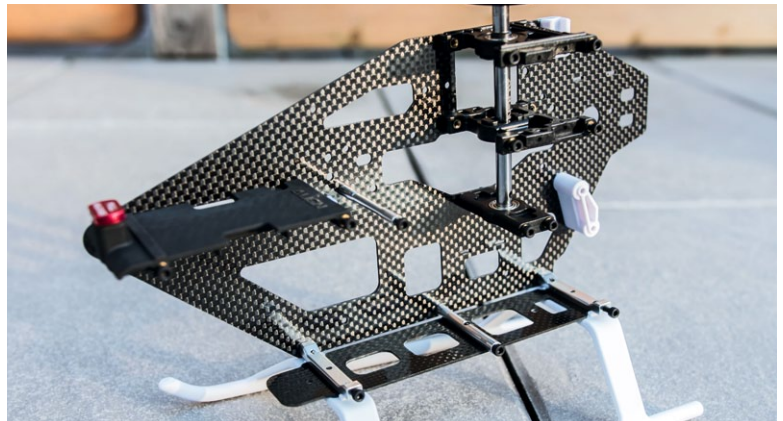
Das halboffene Chassis mit einer Seitenplatte verdeutlicht den konstruktiven Aufbau
