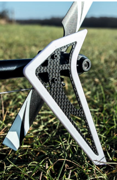
Die Heckfinne besteht im Inneren aus Carbon und ist komplett mit einem weißen Kunststoff umrahmt, der die Kanten schön abrundet und außerdem sehr gut sichtbar ist
