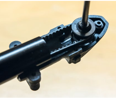
Halboffenes Heckrotor-Getriebegehäuse mit aufgefüdeltem Zahnriemen. In Sachen Länge der Heckrotorwelle gibt es ein Update (siehe Kasten „HECK-PERFORMANCE“)
