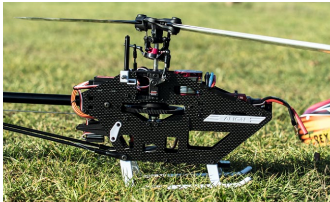
Gesamtansicht der rechten Chassis-Hälfte. Deutlich zu erkennen ist das schrägverzahnte Hauptzahnrad. Das Heckservo sitzt in einem zwischen den CFK-Seitenteilen verschraubten Träger aus Kunststoff
