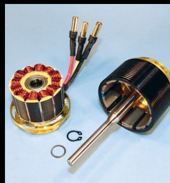
Die Führung der Magnetglocke in 10-Millimeter-Kugellagern sorgt für Langlebigkeit
