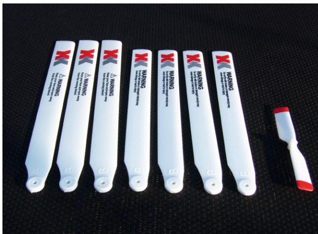
Die schmalen Kunststoff-Hauptrotorblätter des Dreiblatt-Rotors der Ecureuil sind geringfügig (siehe Datenkasten) länger als die des Vierblatt-Rotors (EC 145). Der Heck-Prop ist bei beiden Modellen identisch
