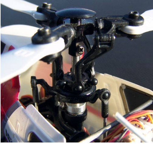
Der Ecureuil-Dreiblatt-Rotor mit Metall-Zentralstück im Detail. Deutlich zu erkennen sind die Y-Anlenkungen. Die drei winzigen Taumelscheiben-Servos sitzen direkt unter der Taumelscheibe
