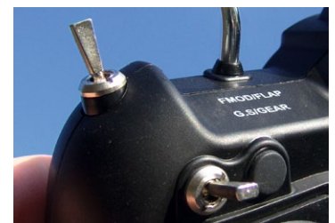
Gasvorwahl- und Flugmodi-Schalter sitzen links (Funktionsbeschreibung im Text)
