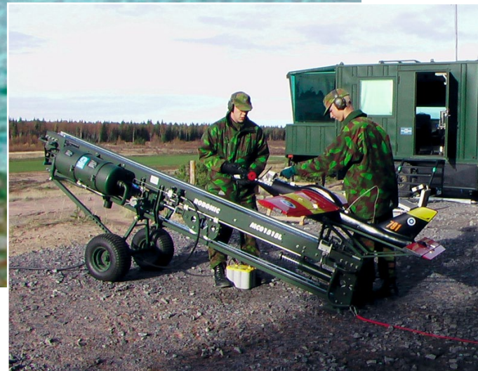
Beim Militäreinsatz erfolgte der Start der Drohnen vom Katapult aus
