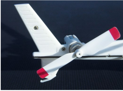
Die Heckausleger sind zwar an beiden Modellen unterschiedlich im Outfit, Antriebsmotor und Prop sind jedoch gleich
