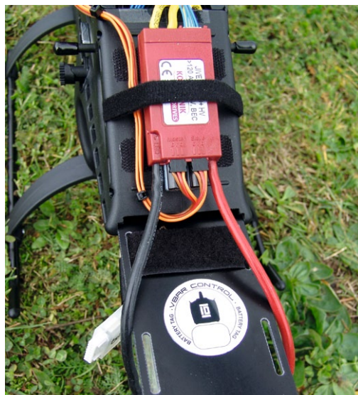
Mit der Akku-ID-Platine werden die mit RFID-TAGS ausgerüsteten LiPos beim Einschieben in den Akku-Schacht berührungslos identifiziert. Daten bezüglich Kapazität, gewünschter Entlade-Tiefe und vieles mehr können automatisch abgerufen werden
