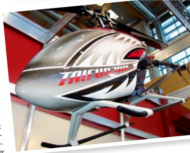
Hauptgetriebe, einen Starrantrieb und die Stromversorgung erfolgt über 6s-LiPos bis zu 3.000 Milliamperestunden Kapazität. Zum Lieferumfang gehören jeweils Motor, Controller, Blätter und lackierte Haube. Auch gesichtet werden konnte der Taifun 700 (Gaudi X7), den Graupner eventuell auch noch ins Sortiment aufnehmen wird.
