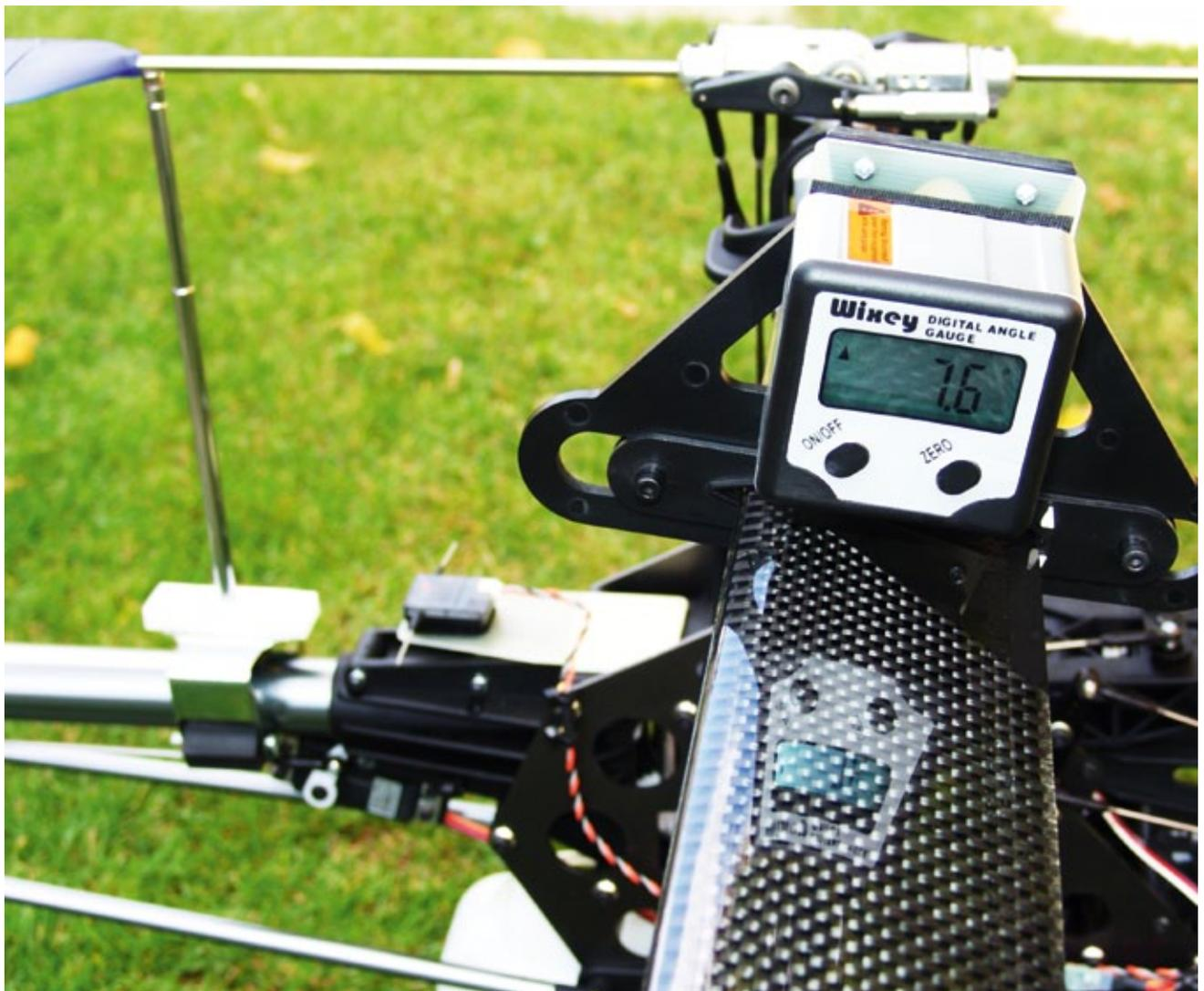
**von Fred Anneck** Als grobe Faustregel beim Pitch-Einstellwinkel gilt: bei Hubschraubern mit Verbrennungsmotorantrieb  $\pm 9$  Grad, bei Elektrohubschraubern  $\pm 12$  Grad Verstellweg. Mit diesen Ausgangswerten wird man in den allermeisten Fällen schon sehr nahe am Optimum liegen. Nicht alle Bedienungsanleitungen definieren hier exakte Vorgaben für ihre Modelle beziehungsweise Antriebe.
