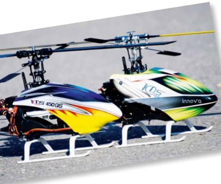
Der Innova 450QS ist mit einem zweiteiligen Kunststoff-Chassis ausgerüstet, das leicht und stabil ist. Hauptrotor, Pitchkompensator und Taumelscheibe sind ebenfalls aus Kunststoff gefertigt, wobei bei den Anlenkungen nicht mit Kugellagern gespart wurde
