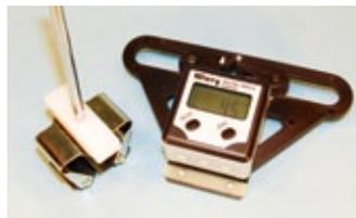
Zusammen mit einem Halter für die Paddelstange erhält man so das Werkzeug zur exakten Bestimmung des Rotorblatt-Einstellwinkels
