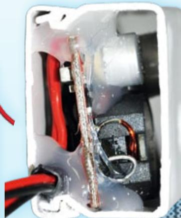
Nach dem Öffnen des LF-Super BEC zeigt sich im Inneren eine Western Robotics-Platine vom Typ Hercules Super BEC, die hier mit viel Heißkleber befestigt wurde
