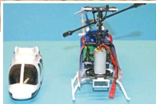
Nach dem Abnehmen des aufgesteckten Rumpf-Vorderteils wird ein Großteil des übersichtlichen Innenlebens zugänglich. Ganz hinten im Rumpf die Empfangseinheit mit den beiden Linearservos
