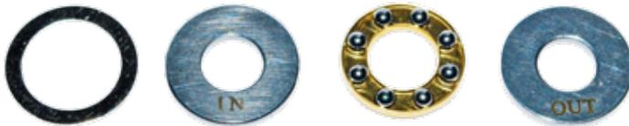
Die Lagerschalen der Drucklager sind mit „IN“ und „OUT“ eindeutig beschriftet und müssen genau so eingebaut werden. Die Lagerschale mit dem größeren Innendurchmesser sitzt immer innen
