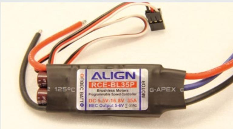
Eine einstellbare BEC-Spannung von 5 bis 6 Volt zeichnet den neuen Align-Controller BL 35P aus. Leider wurde der Governor-Modus nicht verbessert
