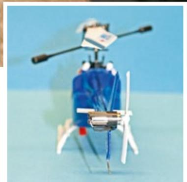
Am Heck agiert für den Drehmomentausgleich ein gesonderter Elektromotor, der mit einem Propeller versehen ist
