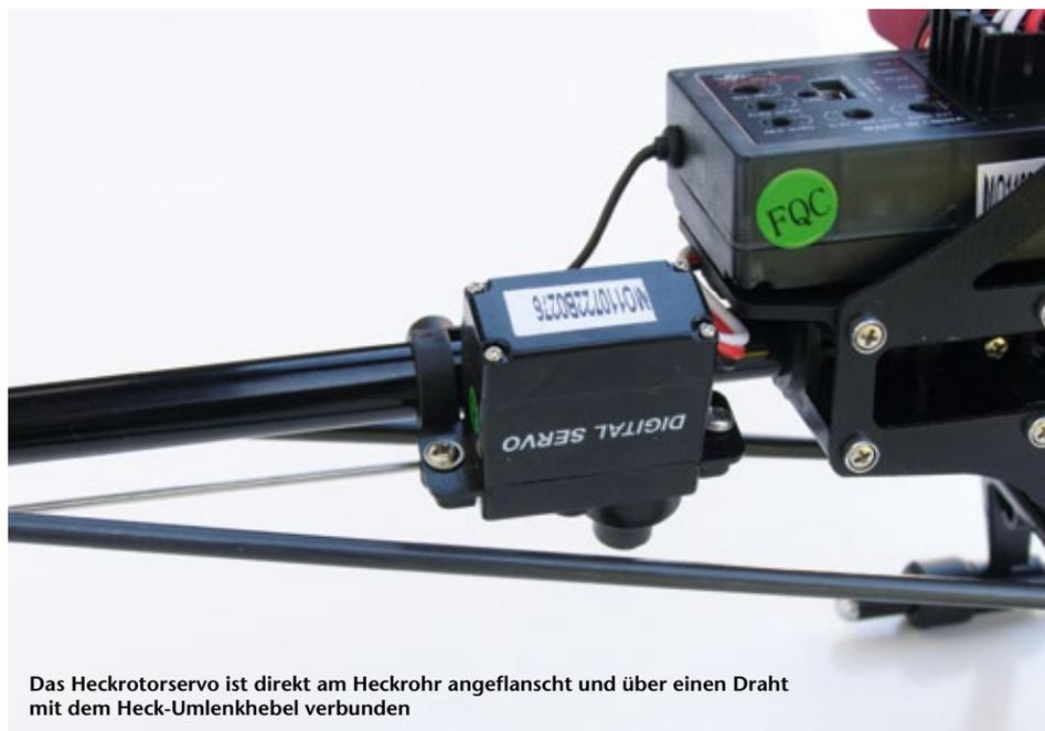
Das Heckrotorservo ist direkt am Heckrohr angeflanscht und über einen Draht mit dem Heck-Umlenkhebel verbunden
