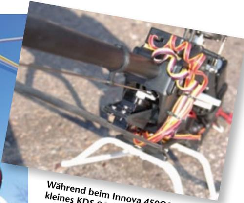
Während beim Innova 450QS ein kleines KDS 9G-Heckrotorservo eingesetzt wird, ...
