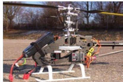
Das Chassis des Innova 450SD ist aus Kohlefaser gefertigt, die Seitenteile werden mit Alu-Lagerböcken verbunden. Der gesamte Hauptrotor nebst Taumelscheibe und Kompensator ist aus Aluminium gefertigt
