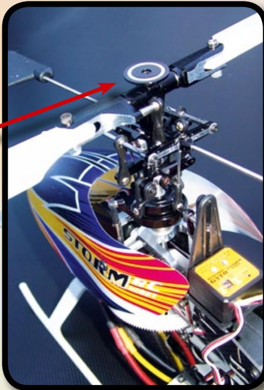
Auch der Hauptrotor mit seiner untenliegenden Stabilisierungsstange ist weitestgehend aus Ganzmetall aufgebaut. Das hinter der Taumelscheibenführung untergebrachte Gyro-System verfügt serienmäßig über Heading-Lock-Funktion
