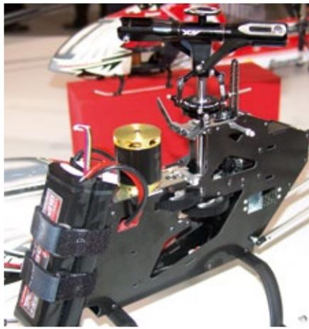
führt. Graupner spricht eine Einsatzempfehlung für das microbeast von BeastX aus und bietet dieses auch ab sofort im Vertrieb mit an. Der Taifun 200 beeindruckt mit folgenden Features: CFK/Alu-Bauweise; Heckrotor mit Riemenantrieb; Stromversorgung über 3s-LiPos; 3D-tauglich. Der größere Bruder Taifun 500 hat ein zweistufiges
