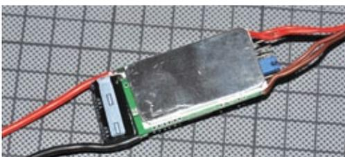
Das Alublech ist thermisch leitend mit der Platinenrückseite verklebt
