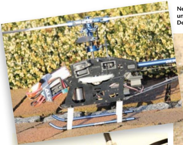
Neu designed wurde die Akkuaufnahme, unter der auch der Controller Platz findet. Der Empfänger sitzt hinten im Chassis
