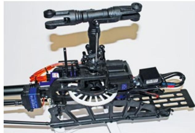
Die Anordnung der RC-Komponenten ist beim Revolution 500 sehr übersichtlich. Dank einteiligen Kunststoff-Anlenkungen ist die Ansteuerung der Taumelscheibe fest vorgegeben und erfordert keine weiteren Einstellarbeiten
