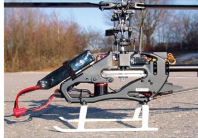
Seitenansicht des Innova 450QS mit Blick auf das Hauptgetriebe, dessen Zahnräder einen guten Rundlauf aufweisen
