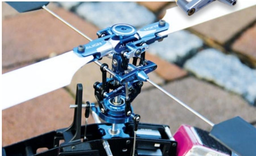
Komplett neu konstruiert wurde der Rotorkopf. Die Mischhebel sitzen nun direkt am Blatthalter
