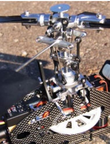
Blick auf den Hauptrotormast des Innova 450QS. Deutlich zu erkennen sind auch die beiden vorne im Chassis montierten Rollservos der 120-Grad-Anlenkung und das hinten links eingebaute Nickservo
