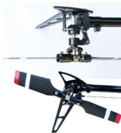
Der über eine Welle angetriebene Heckrotor mit seinem Kunststoff-Kegelradgetriebe und der spielarmen Ansteuerung über eine konventionelle Schiebbehülse
