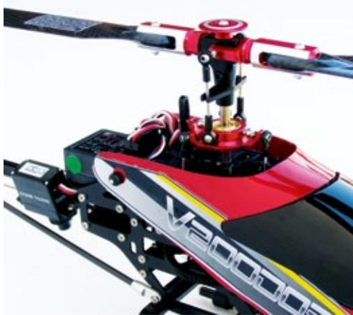
Blick auf die Flybarless-Hauptrotoreinheit mit den beiden Rotorkopfgestängen und deren Gabelführungen
