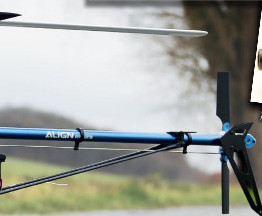
antrieb meistens die Kegelräder Karies bekommen, steckt ein Riemen solche Vorfälle meist unproblematisch und ohne Schaden weg. Des Weiteren kann das Heck bei einem Scale-Umbau einfacher über eine Umlenkung oder ähnliches verlegt werden. Wie auch schon beim Rotorkopf ist das Heck blau eloxiert und komplett aus Aluminium gefertigt.
