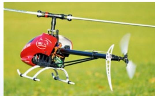
Hauben- und Chassis-Design lassen die Verwandtschaft zum Alien 500 erkennen, von dem der Revolution 500 auch einige technische Features geerbt hat. Im Gegensatz zum Alien ist der Motor beim Revolution 500 hängend eingebaut, wodurch der Schwerpunkt tiefer sitzt und für eine höhere Flugstabilität sorgt
