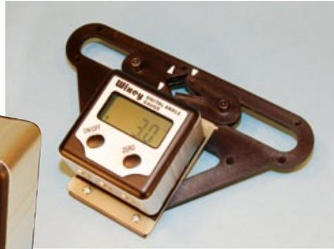
... mit einem elektronischen Winkelmessgerät für Sägeblätter ...
