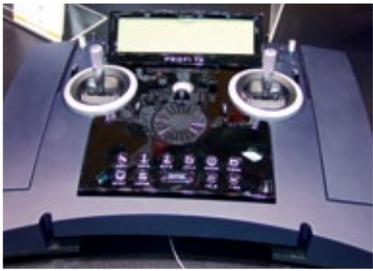
Die besonderen Merkmale aller Profi-TX-Typen sind nicht nur das Breitbild-Display (5,8 Zoll) und das große, in der Mitte befindliche 3D-Rad zur Programmierung, sondern auch die Technologie inside: Hier wird zur Reduzierung von Steckverbindungen ein modernes Flexleiterplattensystem verwendet, zudem wurde die Abstrahltechnik des Antennensystems verbessert.
