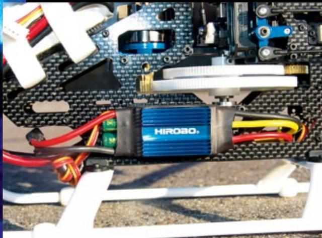
Blick von unten auf die untere Lagerleiste des Chassis. Dahinter sind die drei Steckverbindungen von Controller und Motor zu erkennen. Hier muss wegen der schlechten Zugänglichkeit mit Zange und Pinzette gearbeitet werden, um Stecker und Buchsen miteinander zu verbinden
