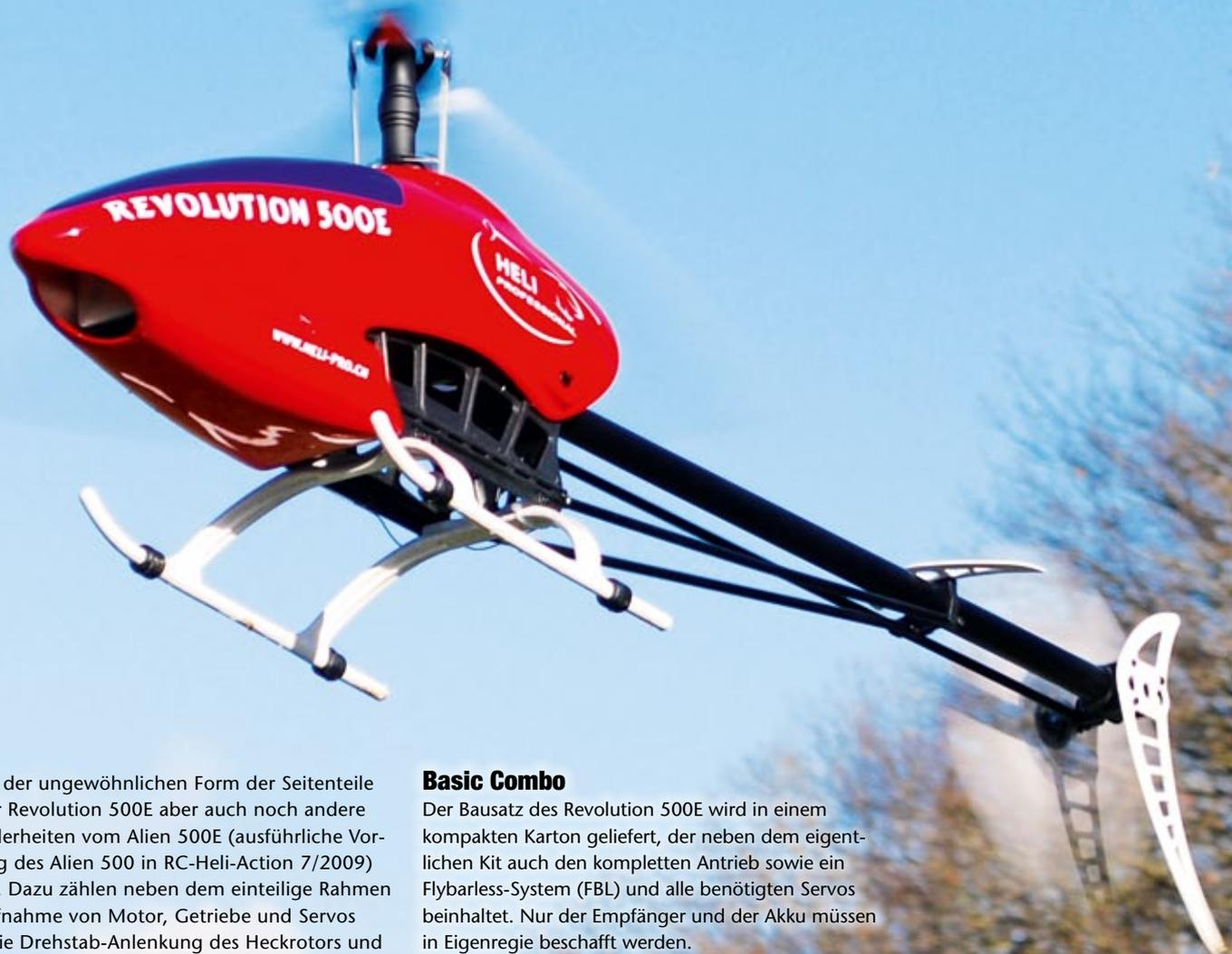
Neben der ungewöhnlichen Form der Seitenteile hat der Revolution 500E aber auch noch andere Besonderheiten vom Alien 500E (ausführliche Vorstellung des Alien 500 in RC-Heli-Action 7/2009) geerbt. Dazu zählen neben dem einteiligen Rahmen zur Aufnahme von Motor, Getriebe und Servos auch die Drehstab-Anlenkung des Heckrotors und nicht zuletzt die sichelartige Form von Seiten- und Höhenleitwerk.
