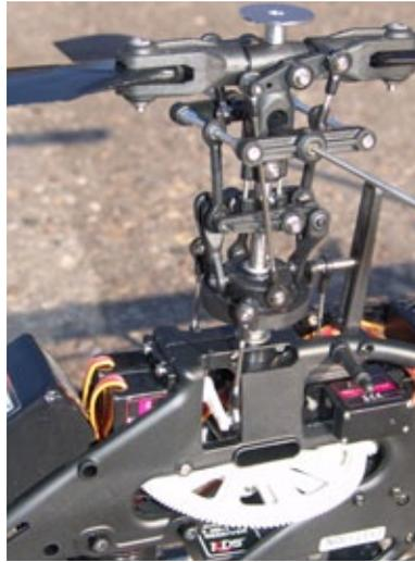
Der Innova 450SD besitzt edle Alu-Komponenten und ein CFK-Chassis. Hier sitzen die beiden Rollservos direkt am Alu-Domlager
