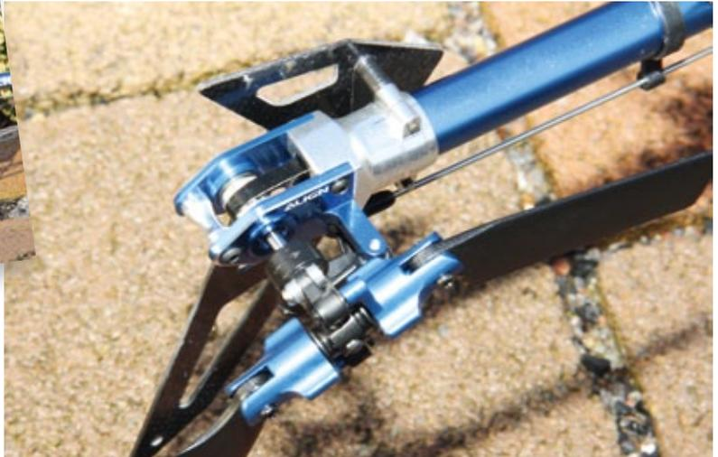
Nichts geändert wurde am Heckrotor-Gehäuse und am Heckrotor selbst; hier kommen die bewährten Komponenten des Vorgängers zum Einsatz
