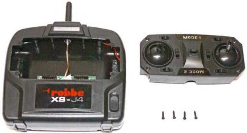
Nach dem Herausdrehen der vier Blechschrauben wird die Steuereinheit des Senders einfach um 180 Grad gedreht wieder montiert und somit von Mode 2 des Lieferzustands auf Mode 1 umgebaut
