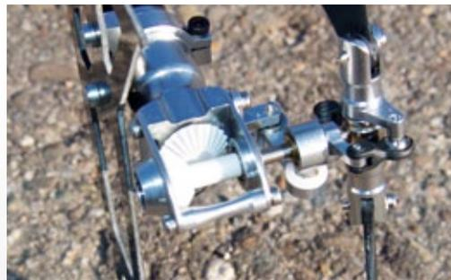
Die edle Alu-Heckvariante des Innova 450SD. Der Antrieb erfolgt über eine Starrwelle. Das 90-Grad-Kegelradgetriebe läuft leise und ist sehr robust. Für eine relativ spielfreie Anlenkung sorgt unter anderem auch eine in der Schieböhülse eingespreste Delrinhülse
