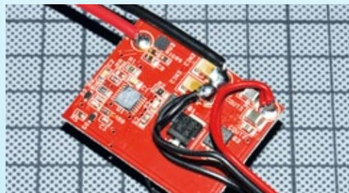
Detailansicht der Platinenoberseite beim Hercules Super BEC. Mit den vorne sichtbaren beiden Mikroschaltern können vier verschiedene Ausgangsspannungen gewählt werden
