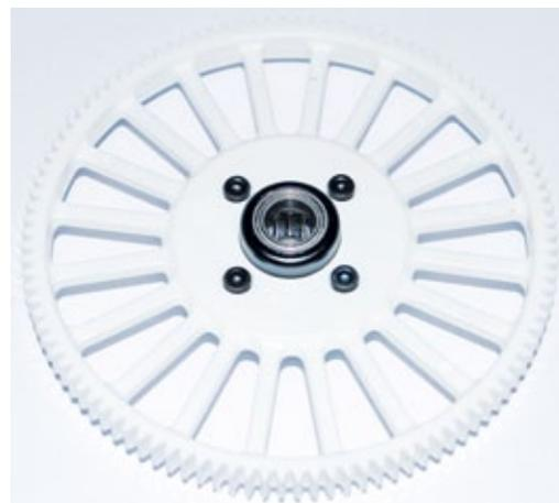
So muss ein guter Freilauf aussehen: Der eigentliche Klemmrollenfreilauf des Hauptzahnrad sitzt in einem soliden Alugehäuse und wird beidseitig von groß dimensionierten Kugellagern abgestützt
