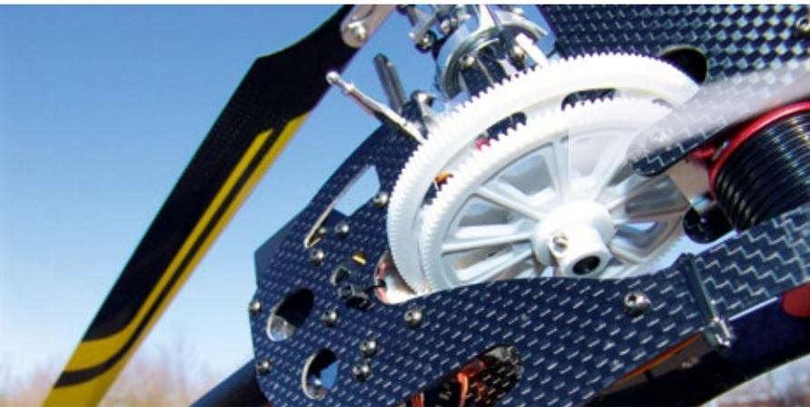
Beim Innova 450SD werden die gleichen Hauptzahnäder wie beim QS verwendet. Lediglich beim Heckabtrieb gibt es Unterschiede: QS => Zahnriemenantrieb, SD => Kegelradgetriebe für Starrwellenantrieb. Das kleinere der beiden Hauptzahnäder ist fest mit der Rotorwelle verbunden und führt zu einem in der Autorotation mitdrehenden Heckrotor (Freilauf sitzt im oberen Hauptzahnrad)
