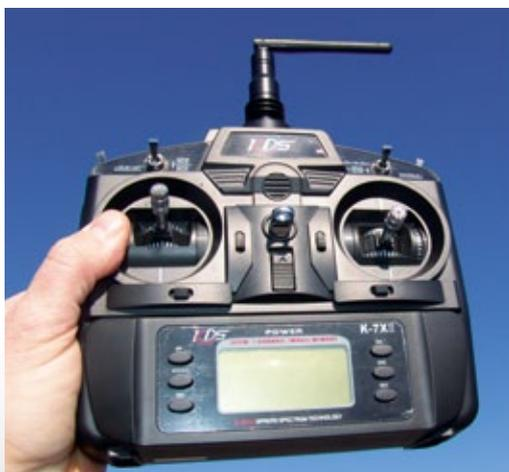
Die mitgelieferten Siebenkanal-KDS-Handsender K-7X II verfügen über sieben Modellspeicherplätze. Die Programmierung erfolgt über die sechs Tasten neben dem gut ablesbaren Display. Externschalter für Idle-Up, Dual Rate, Gyro-Umschaltung und Throttle-Hold sitzen gut erreichbar an der Vorderseite des Gehäuses
