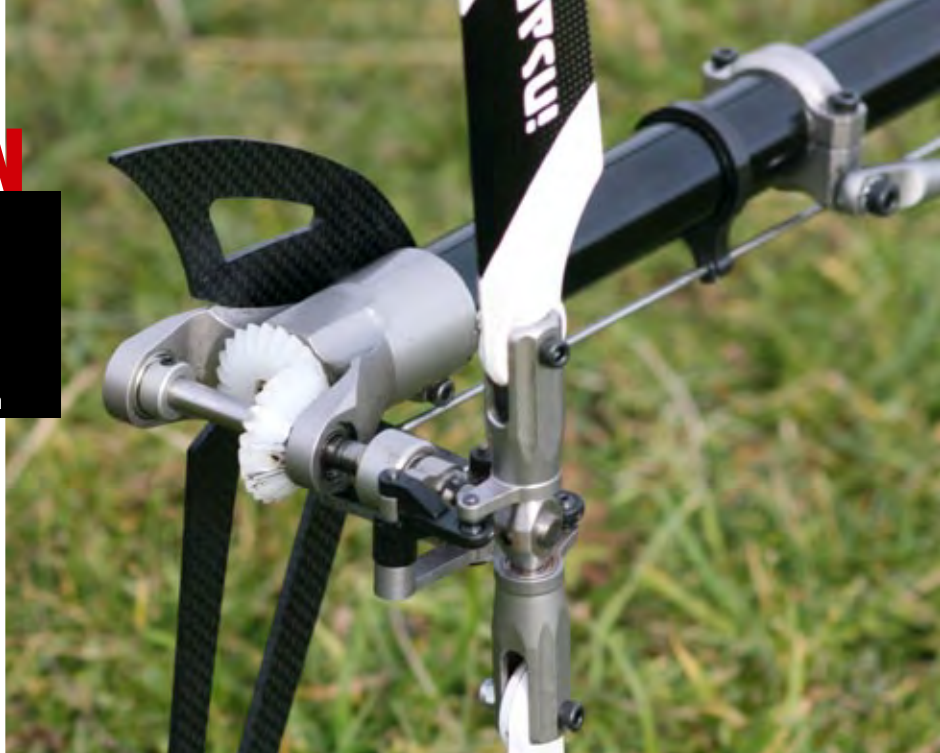
Das präzise Heckrotorgetriebe mit den sauber laufenden Delrinzahnradern. Der Heckrotor hat Alu-Blatthalter
