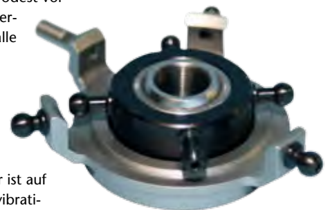
Die aus Alu gefertigte Taumelscheibe mit einstellbarem Lagerspiel
