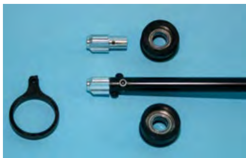
Die Heckrotor-Antriebswelle mit Kupplungsstücken und der zweifachen Lagerung im Heckrohr. Die Gestängeführung ist aus schwarzem Delrin gefräst
