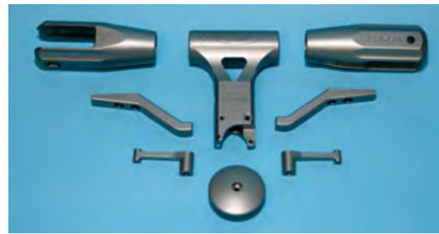
Die sauber gefertigten Aluminiumteile des Hauptrotorkopfs
