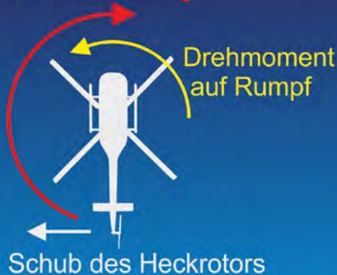
Abbildung 1: Der rechtsdrehende Rotor (von oben gesehen) bewirkt ein Drehmoment – der Rumpf will sich nach links drehen. Um das zu verhindern, muss der Heckrotor einen Schub nach links bewirken, indem er eine Strömung nach rechts erzeugt
