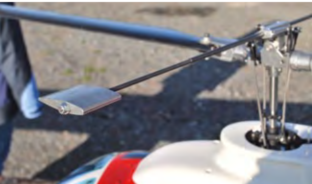
Blick auf die Metall-Steuerflügel, die auf der Stabstange mit einer Stoppmutter gesichert sind
