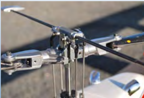
Der Hauptrotorkopf mit seinen Mischhebeln und Paddelstangen-Anlenkung. Die Dämpfung erfolgt im Zentralstück mit einem Gummi-Formteil, ähnlich wie heute noch bei manchen Hirobo-Rotorköpfen
