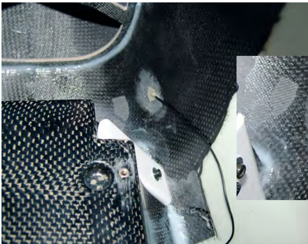
Hier wird das dünne Carbon-Laminat in der Hughes 500 mit Leitlack kontaktiert. Die daran angeschlossene Litze geht zur Motorträgerplatte und in den Heckausleger
