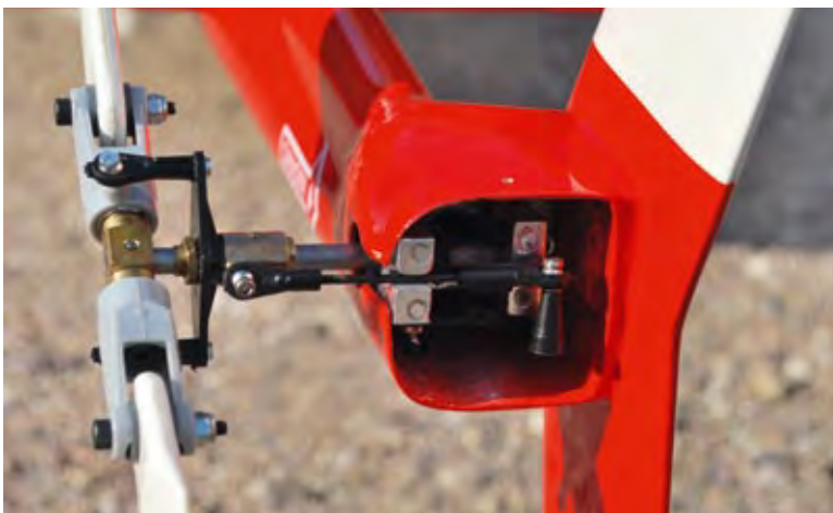
Das Gestänge vom Umlenkhebel zur Schiebbehülse ist in einem Schlitz des Gehäuses geführt. Die Messing-Heckrotornabe ist mit Hilfe eines Querstifts mit der Welle verbunden
