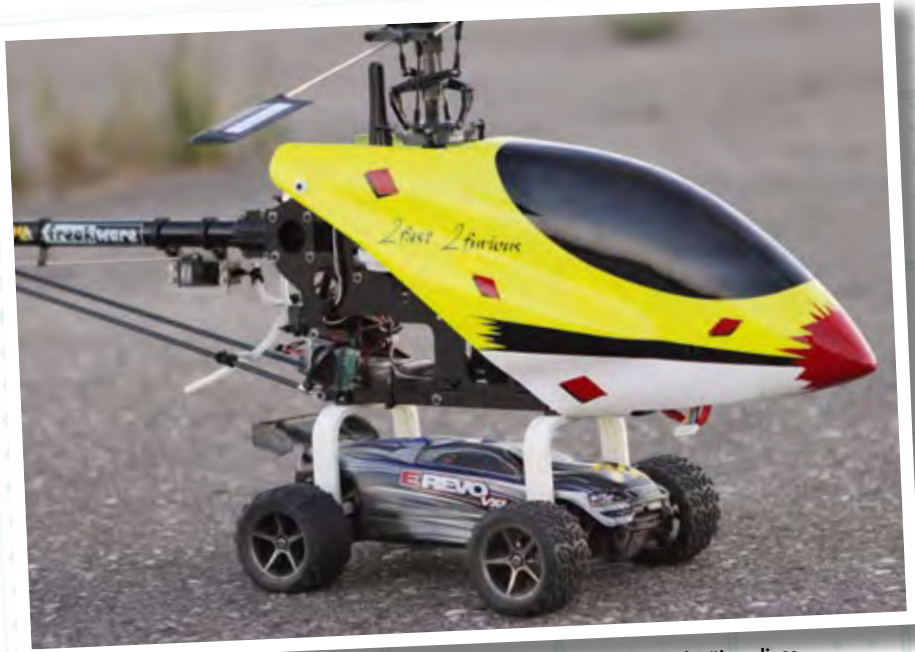
Die Spezialkufen des HeliGraphix Sky Car (ausführlicher Bericht über diese Stunt-Aktion siehe RC-Heli-Action 10/2012) entstanden ebenfalls per Rapid Prototyping. In diesem Falle kam selektives Lasersintern zum Einsatz
