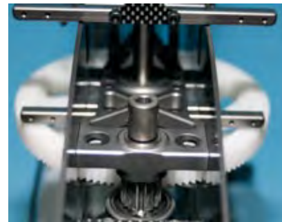
Die Sechskant-Starteraufnahme für den Anlasser. In der Kupplung darunter ist dafür ein Freilauf integriert
