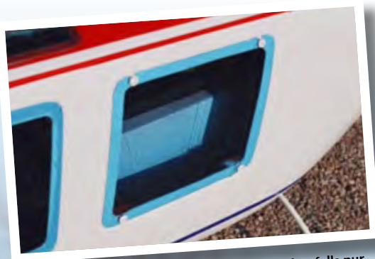
Mit den herausnehmbaren Seitenscheiben, ebenfalls nur geklemmt, kommt man sehr schön an alle Einbauten, ohne jedes Mal den Rumpfdeckel abnehmen zu müssen
