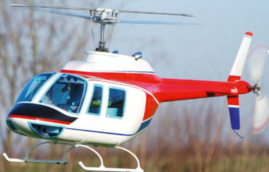
Mit den herausnehmbaren Seitenscheiben, ebenfalls nur geklemmt, kommt man sehr schön an alle Einbauten, ohne jedes Mal den Rumpfdeckel abnehmen zu müssen
