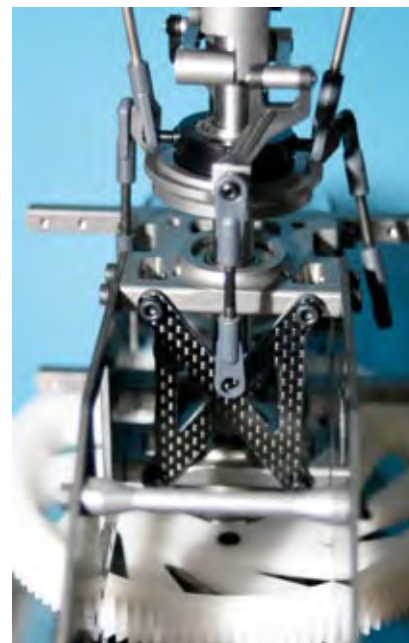
Die zur Taumelscheibe führenden Gestänge
