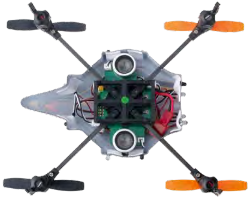
Ansicht von unten. Das Besondere am Infra X sind die neben dem Akkuschacht befindlichen Ultraschall-Sensoren. Zur Hindernis-Erkennung sind im Rand der Haube noch zusätzlich Infrarot-Sensoren untergebracht
