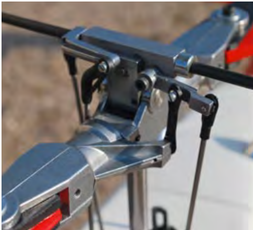
Der Hauptrotorkopf mit seinen Mischhebeln und Paddelstangen-Anlenkung. Die Dämpfung erfolgt im Zentralstück mit einem Gummi-Formteil, ähnlich wie heute noch bei manchen Hirobo-Rotorköpfen
