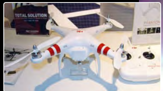
Der Phantom ist ein Ready-to-Fly-Multikopter mit integrierter GPS- und Magnetkompass-Stabilisierung. Das GPS-Modul sitzt geschützt auf der Zentralplatine innerhalb des Gehäuses
