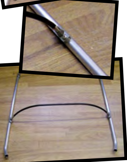
Die Aufnahmen für die Kufenbügel hatten eine Bohrung von 4,33 Millimeter (mm) und mussten auf 5 mm aufgebohrt werden. Die Lage dieser Befestigungen ist auf den Kufenrohren mit jeweils zwei Befestigungsbohrungen vorgegeben. Eine spätere Nachbiegen der Bügel sorgte dafür, dass die Kufen spitzen jetzt gerade stehen
