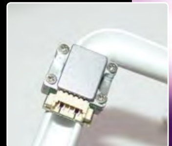
Der Magnetkompass des Phantom sitzt an einer Kufenstrebe, um möglichst weit von elektromagnetischen Feldern der Zentralplatine entfernt zu sein
