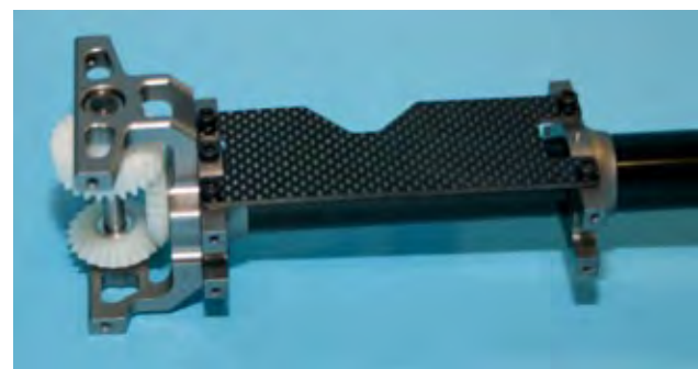
Die Halter des Heckrohrs, bestehend aus den beiden Flanschen, werden mit dem Heckabtrieb verschraubt. Das ergibt zusammen mit der CFK-Platte eine absolut steife Anbindung des Heckrohrs
