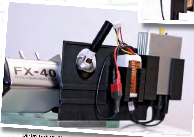
Die im Text erwähnten passgenauen Teile, um FPV-Equipment schnell und ohne dauerhafte Modifikation an einen bestehenden Sender und ein Stativ zu befestigen. Dank Rapid Prototyping sind Kreativität und Möglichkeiten kaum mehr Grenzen gesetzt
