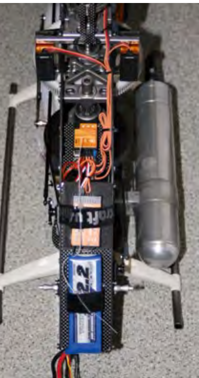
Blick von oben auf die Frontpartie des Whiplash. Das microbeast ist auf der dafür vorgesehenen Plattform montiert. Davor liegen der BeastX-Empfänger und der Empfängerakku. Durch die geringen Abstände zueinander ergibt sich eine einfache Verkabelung
