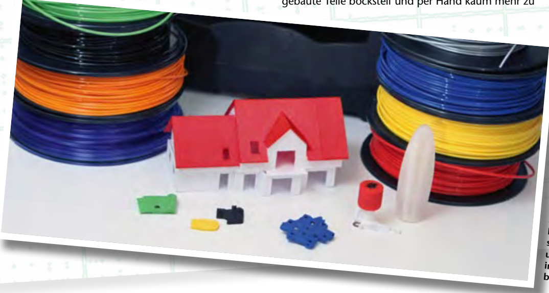
Standardmäßig produziert RepCop Teile in weiß, weil dies ein universelles Finish beispielsweise durch Lackieren ermöglicht. Verfügbar sind jedoch auch etliche weitere Farben, darunter sogar semi-transparente Typen, um Gegenstände von innen heraus durch LED beleuchten zu können
