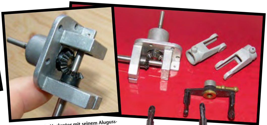
Auch die Heckrotor-Pitchbrücke ist werkseitig bereits vormontiert
