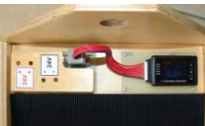
Je nach aufgesetztem Kodierstecker stehen 12V/120Ah oder 24V/60Ah zur Verfügung. Es ist immer nur der jeweils dafür passende Einzelzellenabgriff kontaktierbar
