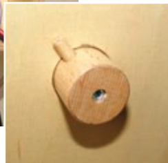
Der Querbolzen am Tragegriff wird durch eine Madenschraube gehalten
