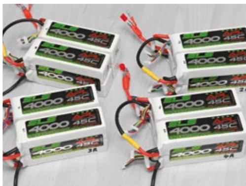
16s-LiPo-Packs gibt es weder zu kaufen, noch werden sie gegenwärtig von Ladetechnik abgedeckt. Je nach benötigtem Formfaktor ist es daher erforderlich, sie aus vier 4s-Einzelpacks zusammenzustellen. Ratsam ist es zudem, alles zerlegbar zu gestalten: Denn bei internationalem Transport dürfen bestimmte Energiedichten pro Akku nicht überschritten werden
