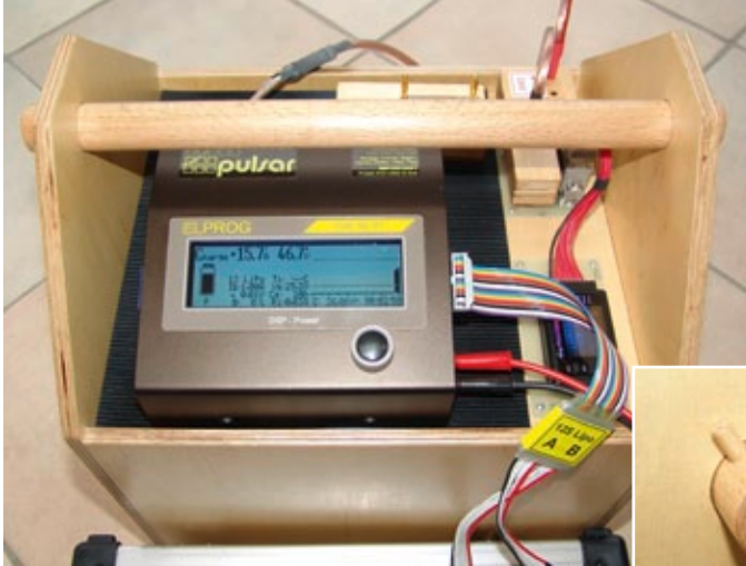
Der Pulsar 3 macht deutlich Dampf. Über 3C-Laderate an 12s-LiPo sind nicht zu verachten
