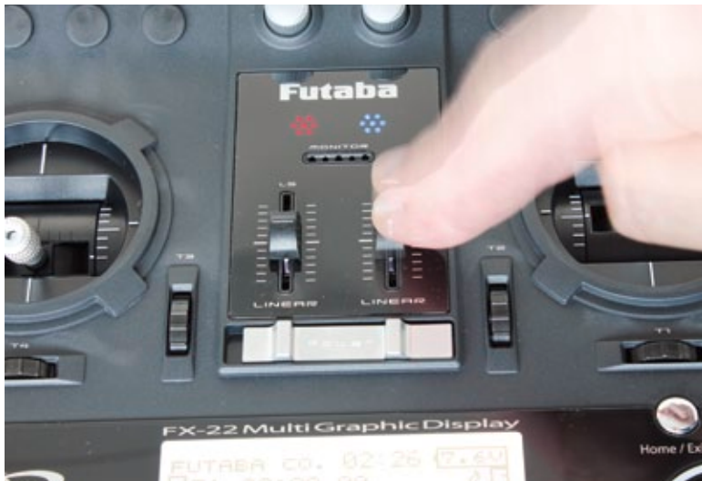
Komfortabel sind die in der Mitte integrierten, gut rastenden Schieberegler
