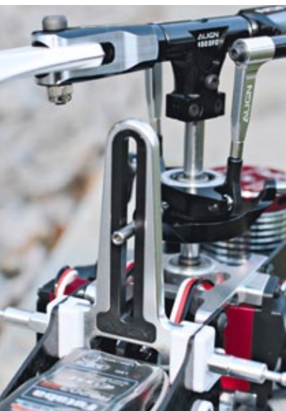
Die neue Alu-Taumelscheibenführung. Der Kunststoffeinsatz soll den Verschleiß minimieren und dafür sorgen, dass die Taumelscheibe spielfrei in der Führung läuft
