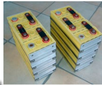
Stahlbänder, die stirnseitig mit Aluminiumplatten verschraubt sind, sorgen für einen mechanisch stabilen Verbund
