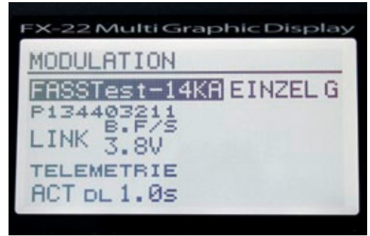
Telemetrie ist nur im FASSTest-Modus möglich. Der Zyklus, Telemetriedaten zu empfangen, ist veränderbar
