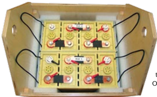
Blick in die Kiste: Die Zellenpacks lassen sich durch Nylon-Schlaufen leicht entnehmen und sind zu den Wänden hin abgepolstert
