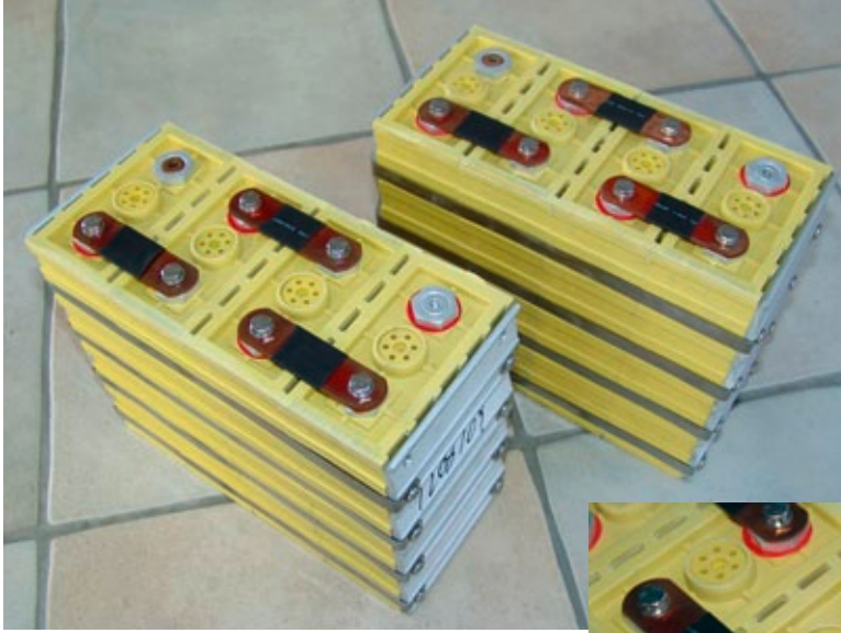
Die beiden 4s LiFeYPO4-Zellenpacks kommen von der Firma Faktor GmbH fertig konfektioniert als Ersatz für herkömmliche 12V-Autobatterien
