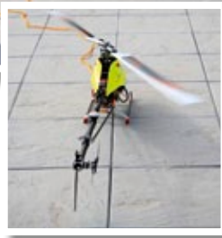
Start frei! Aufgrund der begrenzten Akkukapazität sollte es nicht länger als 20 Sekunden dauern, bis die Payload angehoben wird
