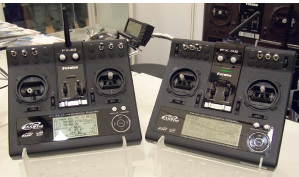
FX-22 (links) und die große FX-32 im Vergleich. Zwar handelt es sich im Wesentlichen um das gleiche Gehäuse, jedoch ist das Display der FX-32 deutlich größer
