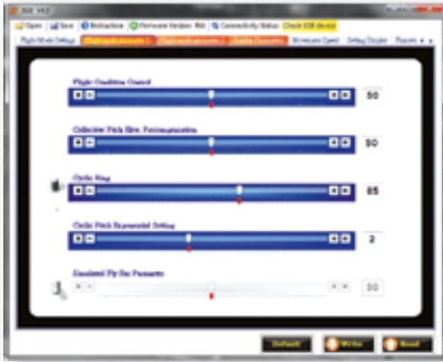
Im Flight-Mode-Parameter-Menü 1 kann das Flugverhalten an die Gewohnheiten des Piloten angepasst werden
