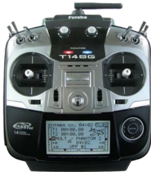
Der neue Phantom 2-Sender ist nun ein FASST-kompatibler Frequenzhopper, der die ganze Bandbreite nutzt
