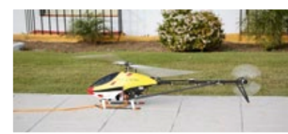
Landung mit vorbildlichem Ablegen des Seils außerhalb des Gefahrenbereichs des Heckrotors. Die Temperaturen von Motor und Controller liegen gerade mal bei rund 60 Grad
