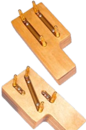
Das Innenleben der Kodierstecker. Oben die Parallelschaltung (4s2p => 12V/120Ah), unten die Serienschaltung (8s1p => 24V/60Ah)
