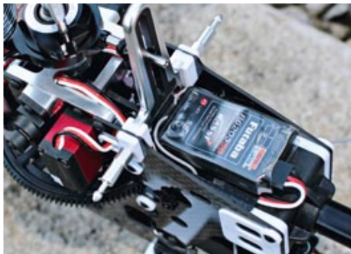
Der robbe/Futaba-Empfänger R6203 S-BUS bekommt seinen Platz auf der Gyro-Plattform oberhalb des Heckrohrhalters
