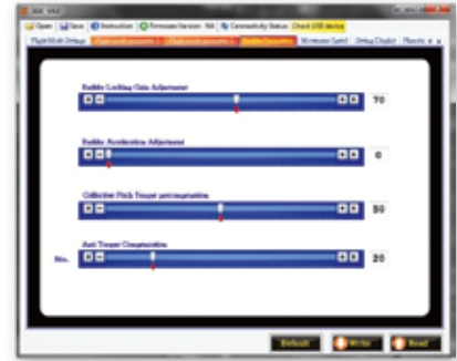
Im Rudder-Parameter-Menü findet man die Gyro-Einstellungen, das Einrastverhalten und den Drehmomentausgleich
