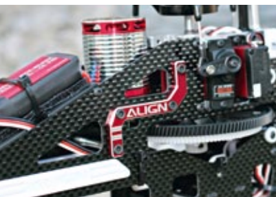
Die rot eloxierten Alu-Chassis-Verstärkungen werden den Rex optisch enorm auf
