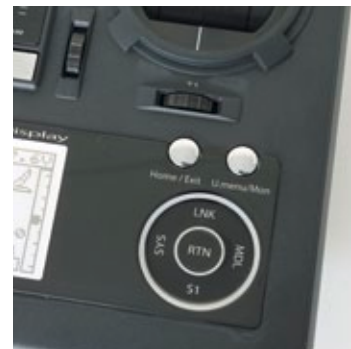
Programmiert wird die FX-22 über die fünf berührungsempfindlichen Tasten des Cap-Touch-Bedienfelds
