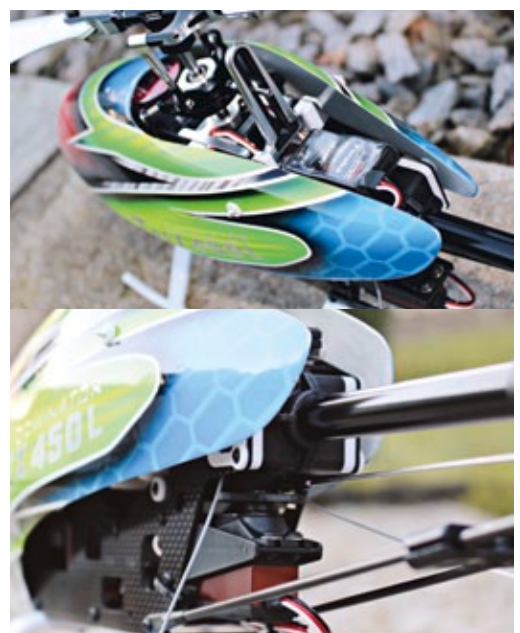
Die Haube des 450L Dominator geht weit nach hinten und schließt eng am Heckrohr ab. Das macht nicht nur optisch was her, sondern kommt auch der Aerodynamik zugute
