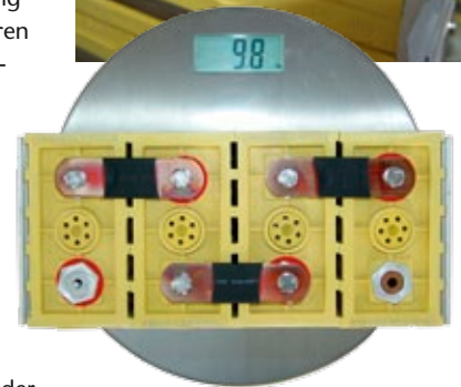
Die LiFeYPO4-Zellen sind mit 9,8 Kilogramm sehr leicht. Eine vergleichbare Pb-Autobatterie mit 60Ah würde locker fünf Kilogramm mehr auf die Waage bringen
