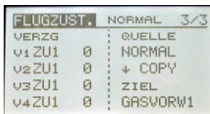
Mühsam erstellte Flugzustände lassen sich einfach kopieren und auf andere Phasen übertragen. Ebenso ist die Umschaltzeit zwischen den jeweiligen Phasen wählbar
