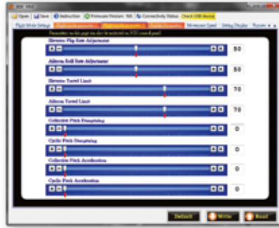
Im Flight-Mode-Parameter-Menü 2 können Drehraten, Limits und das Ansprechverhalten der Taumelscheibe eingestellt werden
