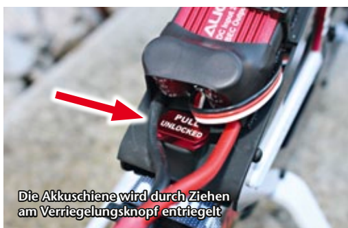
Der LiPo-Akku sitzt auf einer Carbonplatte und wird von vorne in die Kunststoffführung des Chassis eingeschoben
