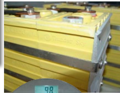
Stahlbänder, die stirnseitig mit Aluminiumplatten verschraubt sind, sorgen für einen mechanisch stabilen Verbund
