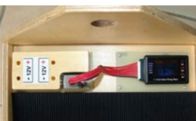
Je nach aufgesetztem Kodierstecker stehen 12V/120Ah oder 24V/60Ah zur Verfügung. Es ist immer nur der jeweils dafür passende Einzelzellenabgriff kontaktierbar
