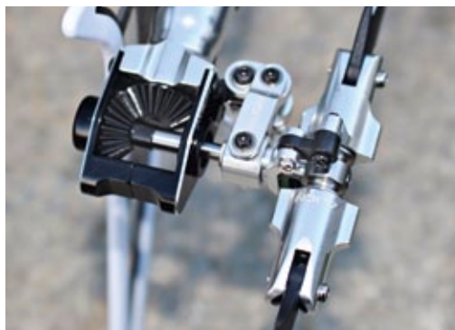
Das Heck des 450L läuft absolut leichtgängig und spielfrei. Die in die Heckblatthalter eingearbeiteten PMGs entlasten das Heckservo
