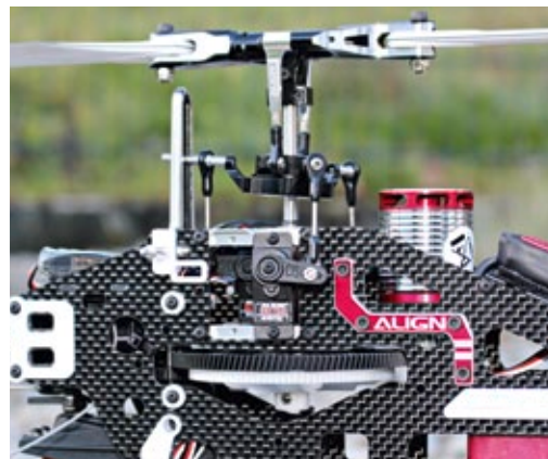
Angenehm leise ist das Laufgeräusch des Hauptgetriebes mit dem schrägverzahnnten 121-Zähne-Hauptzahnrad – auch bei hohen Drehzahlen
