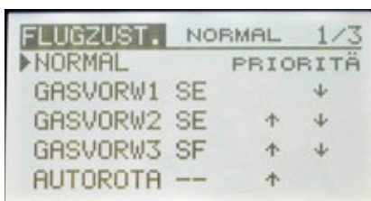
Verschiedene Flugzustände stehen zur Verfügung, deren Priorität sich beliebig konfigurieren lässt
