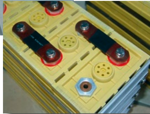
Die Kontaktierung der Einzelzellen erfolgt mit Schrauben M6 und Kupferbändern
