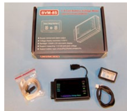
Das BVM-8S kann die Einzelzellenspannung von bis zu acht LiFe verarbeiten und auf seinem hintergrundbeleuchteten Display inklusive Ladezustand darstellen. Ein externer, superlauter Summer (rechts im Bild) gehört zum Lieferumfang
