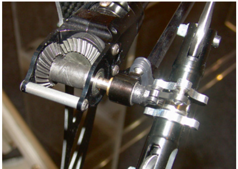
Der Heckrotor mit der Drehstabanlenkung der Schiebehülse ist eine bereits vielfach erprobte und bewährte Lösung. Neu ist seine gedämpfte Montage auf dem Heckrotor, was wirksam mögliche Vibrationen absorbiert. Die Kegelräder sind schräg verzahnt. Die Heckrotor-Blatthaltern haben angefräste Propellermomentgewichte, um die aufzubringenden Servokräfte zu minimieren
