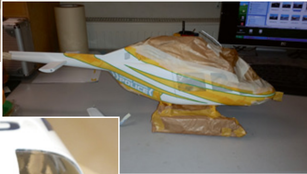
Der fertig abgeklebte Rumpf, bereit für den Farbauftrag
