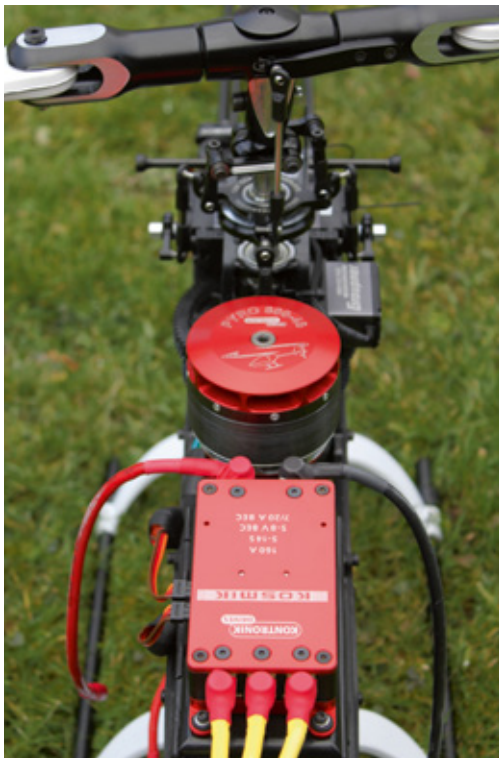
Auf dem Deckel der RC-Box ist der Controller montiert, dessen Motor-Anschlusskabel durch die Box geführt werden
