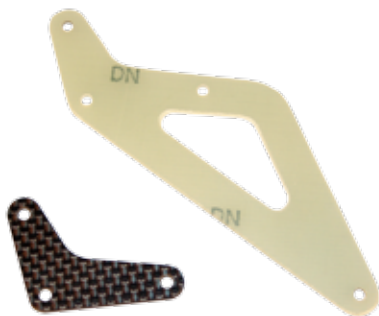
Das kleine, originale Thunder Tiger CFK-Teil zum Halten des RC-Vorbaus aus dem Baukasten und das neue, zum Halten der Akkuplatte beim Akkuwechsel von vorne
