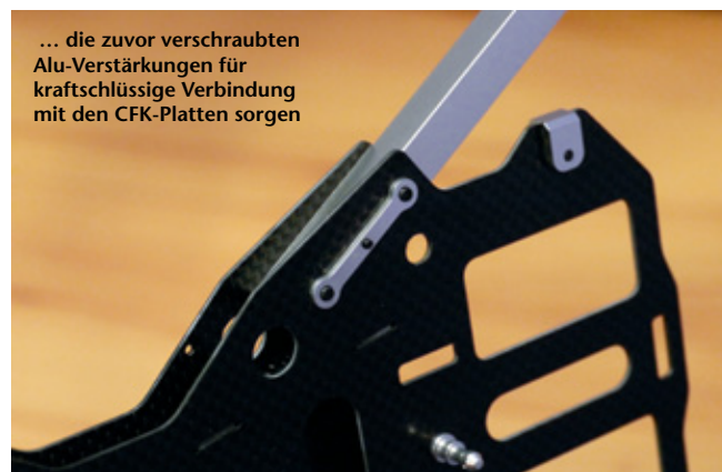
Die Auslegerarme werden zwischen Ober- und Unterplatte verschraubt, wobei ...
