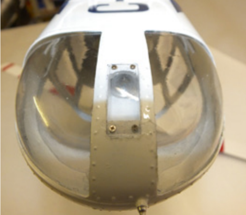
In der Rumpfnase ist der Landescheinwerfer untergebracht
