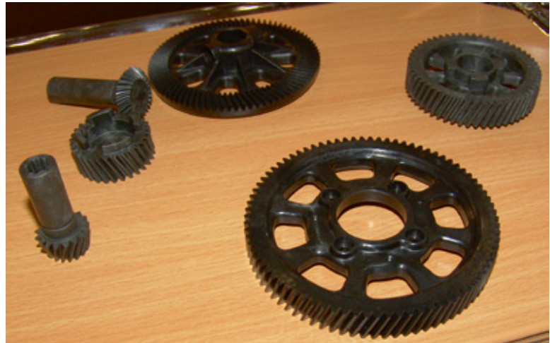
Die schrägverzahnten Zahnräder bestehen aus faserverstärktem Kunststoff und schmieren sich aufgrund unterschiedlicher Materialpaarungen von selbst
