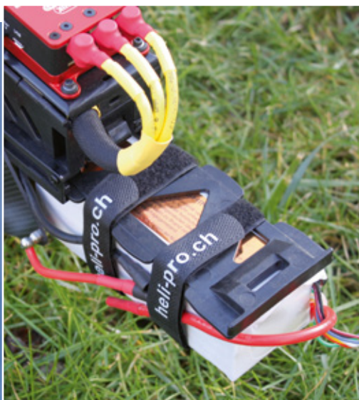
Sehr praktisch und schnell gemacht – der LiPo-Wechsel mittels von vorn einschiebbarer Akkuplatte
