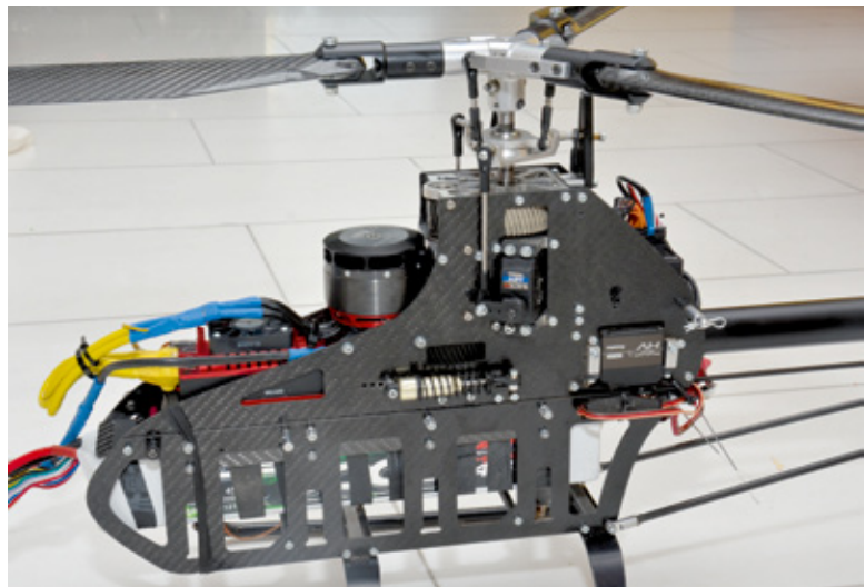
Dank der Akkubefestigung ist ein LiPo-Wechsel schnell bewerkstelligt
