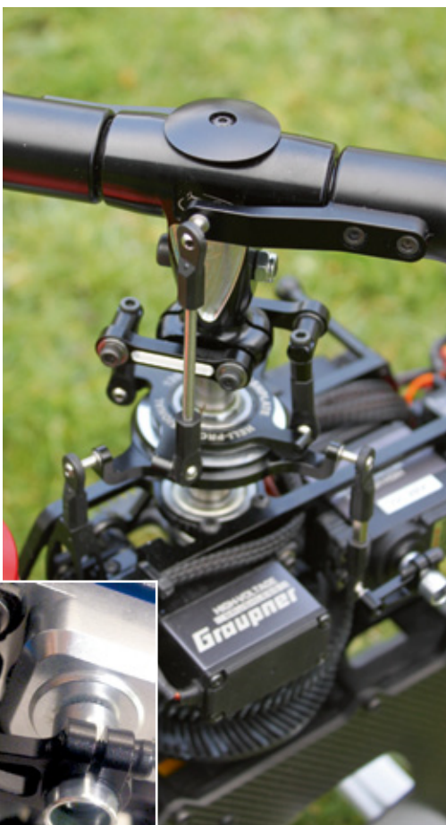
Der mit sämtlichen Anlenkungen versehene Hauptrotor inklusive kugelgelagertem Taumelscheiben-Mitnehmer. Alle drei Taumelscheiben-Servos sind liegend im Chassis montiert
