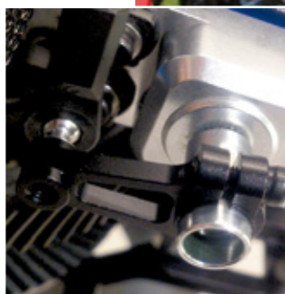
Die im Text erwähnten Servo-Abtriebshebel, die mittels Schraube geklemmt werden
