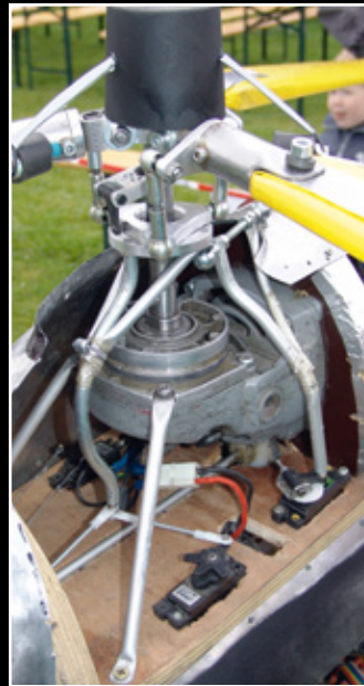
Das umfunktionierte Planetengetriebe aus einem Pressluftschleifer ist am vorderen Rumpfspant angeflanscht. Durch enorm lange Hebelarme und eine einfache, aber sehr effiziente Steuerkinematik sind die benötigten Stellkräfte relativ klein
