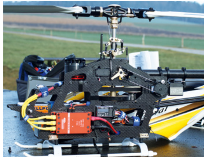
Anordnung von Kosmik-Controller und Flybarless-Elektronik an der linken Chassishälfte
