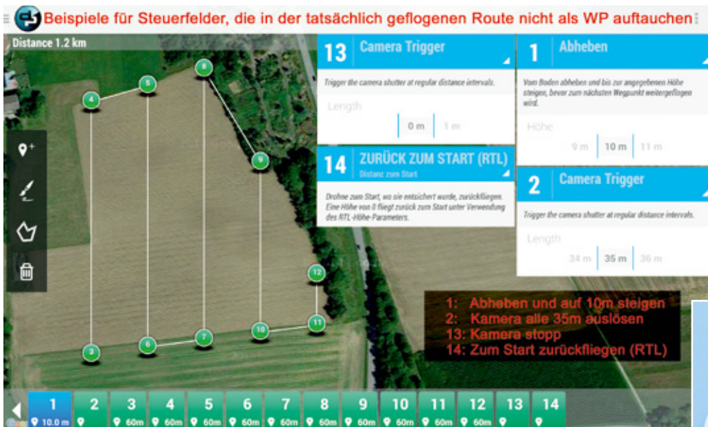
Abbildung 6: Das sind die WP der Survey-Mission aus Abbildung 4. Vier WP werden nicht angefliegen, ihre Funktion zeigen die in die Abbildung einkopierten WP-Beschreibungen
