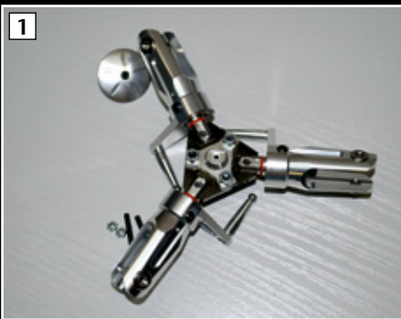
1 Die Blattlagerwellen sind am Rotorstern – im Prinzip eine zentrale Platte – verschraubt
