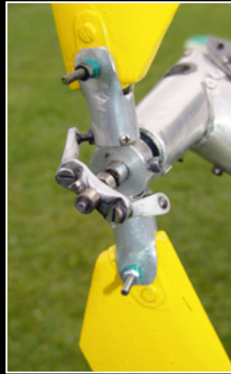
Der Heckrotorkopf mit in der hohlen Welle geführtem Pitch-Steuerdraht (Prinzip System 80 von Schlüter)
