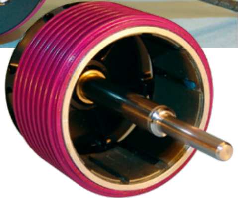
Die Magnetstäbe sind zur besseren Flussverketzung dem Radius des Stators angepasst, die Glocke ist präzisionsgewuchtet. Passscheiben aus Messing auf der Welle positionieren Rotor zu Stator für maximale Überdeckung von Polschuh und Magnet
