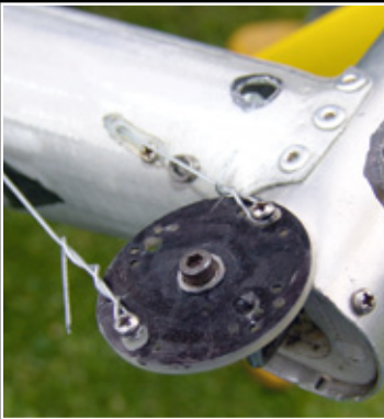
Seilzug-Umlenksegment für den Pitch-Steuerdraht des Heckrotors
