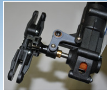
Detail des Heckrotor-Umlenkhebels mit Heckansteuerung auf der Unterseite. Die Heckrotorwelle hat 5 mm Durchmesser, die Kunststoff-Heckblatthalter sind zweiteilig und haben jeweils zwei Kugellagern
