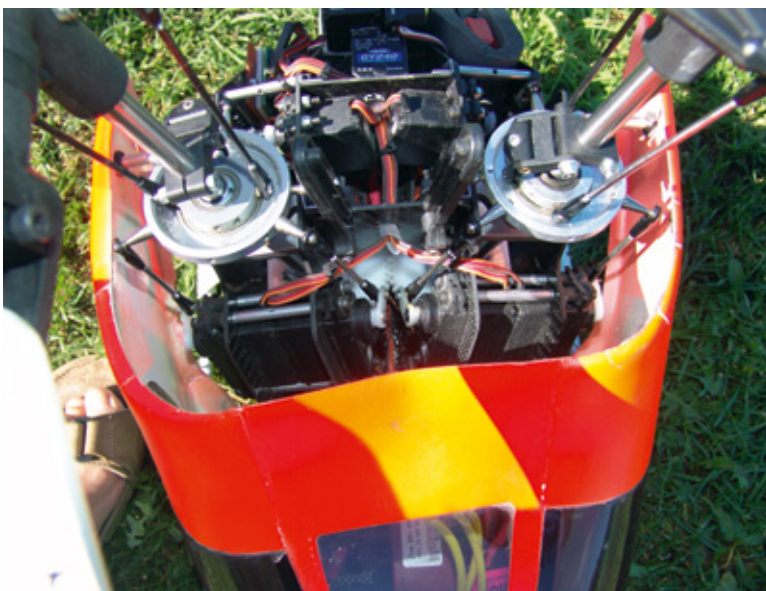
In der Draufsicht ist erkennbar, wie die Taumelscheiben-Servos der beiden Rotormasten angeordnet sind: jeweils beide Rollservos vorne und das Nickservo hinten
