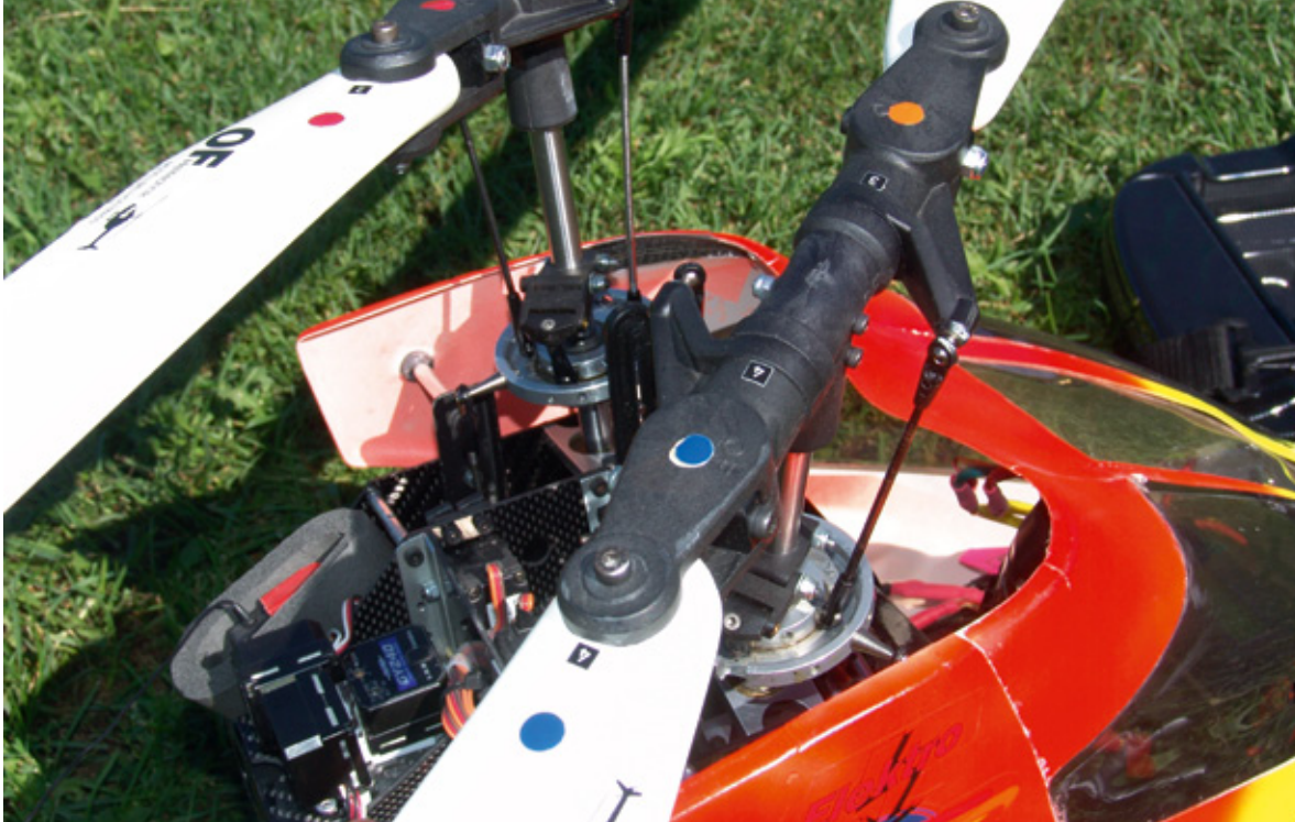
Beeindruckend nah beieinander und ineinanderkämend – die beiden Zweiblatt-Hauptrotoren des Elektro-Flettner-Testbed
