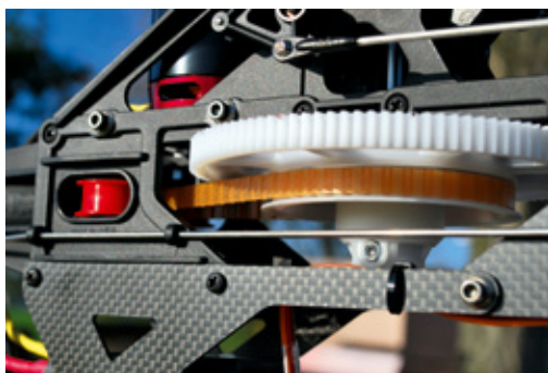
Der Heckriemen-Antrieb erfolgt direkt von der Hauptrotorwelle aus – ohne zusätzliches Getriebe. Gut zu erkennen sind auch die Führungsrollen für den Heckriemen
