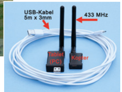
Abbildung 7: Die 3DR-kompatible Telemetrie-Module von ACME. Das Modul mit USB kommt ans Tablet, das kleinere Modul an den Kopter. Auch am PC kann man das USB-Kabel auf diese Weise ersetzen. 433-MHz-Antennen markieren, Verwechslungsgefahr!
