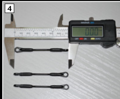
4 Mittel Messschieber lassen sich die drei Rotorkopfgestänge sehr einfach auf gleiche Länge einstellen
