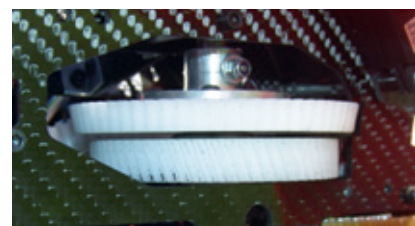
Über ein Ritzel aus der erste Getriebestufe angetrieben wird das untere, schrägverzahnte Hauptzahnrad. Das darüber liegende Synchron-Getrieberad aus Delrin greift in sein Partnerrad des linken Rotormastes
