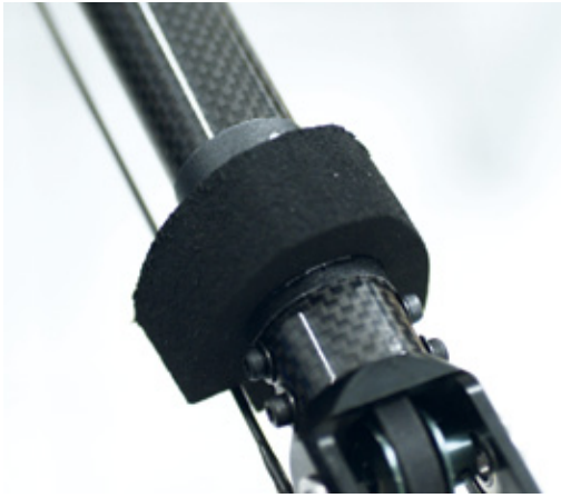
Unmittelbar vor dem Heckrotor befindet sich ein auf dem Heckrohr aufgeklebter Schaumstoffring, um die Vollrumpfverkleidung optimal zu arretieren
