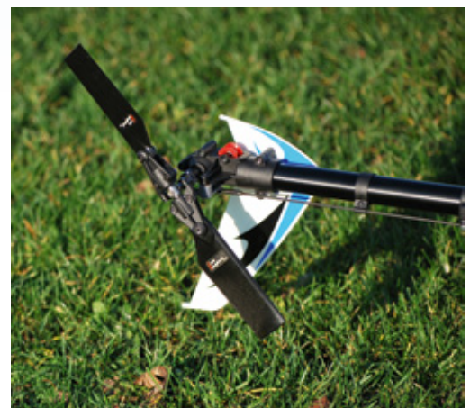
Mit diesen 95 mm langen Radix CFK-Heckblättern erreichen wir die beste Hochachsen-Performance
