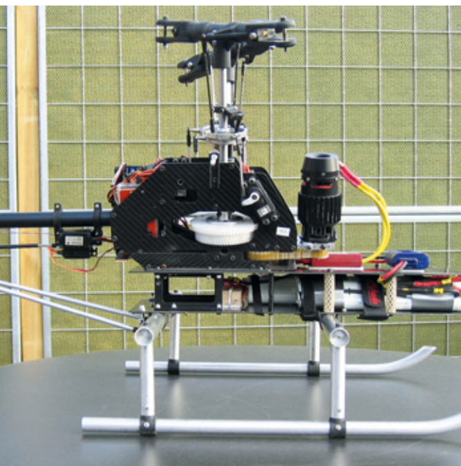
Seitenansicht mit dem erhöhten Alu-Landegestell. Hier war statt des jetzt zum Einsatz kommenden Hacker-Tornado-Motors zu Versuchszwecken noch ein anderes Triebwerk verbaut
