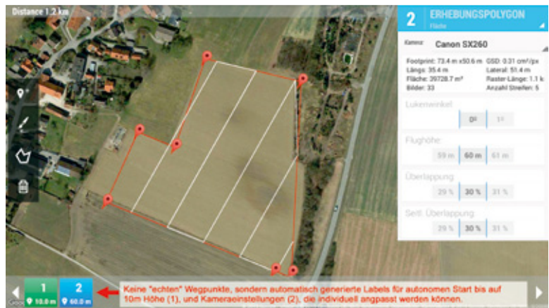
Abbildung 4: Beispiel für eine automatisch generierte komplexe Mission. Rechts das Menü für die Anpassung der Kamera. Die bei uns erst nach Speichern und erneutem Laden der Mission sichtbaren WP zeigt Abbildung 6
