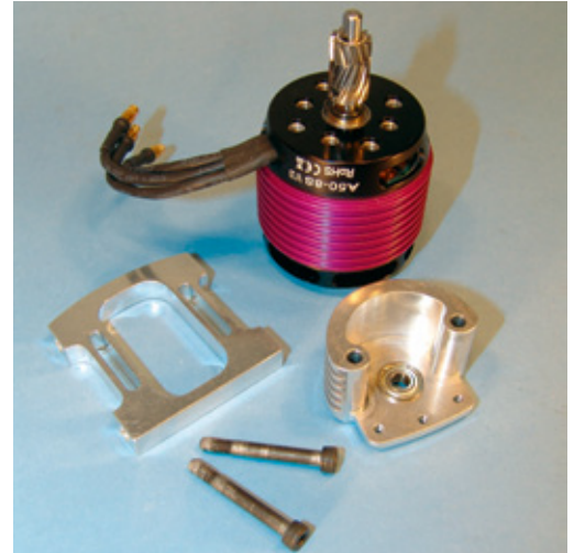
Die M4-Befestigungsschrauben dürfen im LOGO die maximale Länge von 32 mm nicht überschreiten
