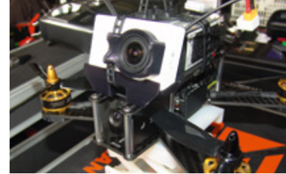
Alle Kopter waren mit jeweils zwei Kameras ausgerüstet: eine für die Live-FPV-Übertragung, die andere für qualitativ bessere HD-Aufzeichnung des Flugs
