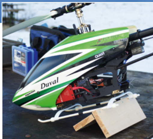
Hat sich bestens bewährt – der im Text beschriebene, selbstgefertigte Heli-Halter aus 22 mm dickem Holz. In dieser nach vorne gekippten Position kann man Controller und Akku von unten her bequem miteinander verbinden
