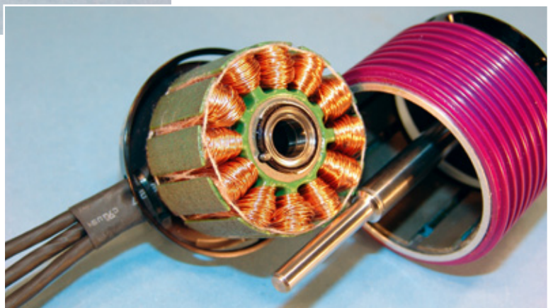
Deutlich zu erkennen – die doppelte, hintere Kugellagerung für lange Lebensdauer. Die Wicklung ist zu den Polschuhen hin sauber mit Faden abgebunden, ein Kabelbinder bündelt die drei Phasenanschlüsse noch vor Verlassen des Motors
