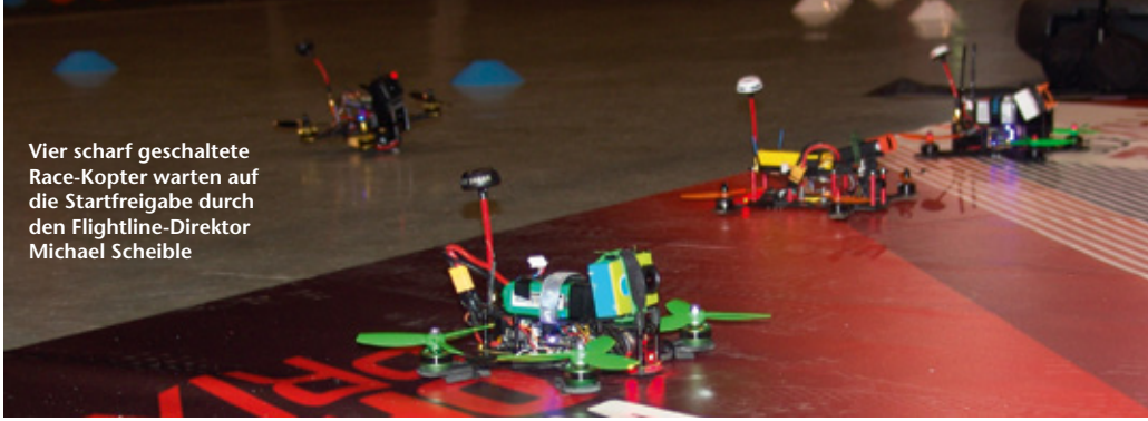
Alle Kopter waren mit jeweils zwei Kameras ausgerüstet: eine für die Live-FPV-Übertragung, die andere für qualitativ bessere HD-Aufzeichnung des Flugs
