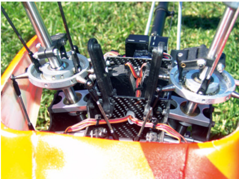
Blick auf die beiden 120-Grad-Taumelscheiben-Anlenkungen, wobei zugunsten besserer Auflösung 40 Millimeter lange Kugelbolzen am Außenring montiert sind – daraus resultiert ein größerer Hebelarm mit weniger Ausschlag
