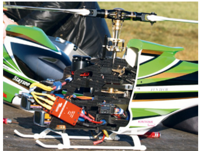
Auf der rechten Chassisseite sitzt der 2s-Pufferakku. Die beiden 6s-LiPo-Antriebsakkus sitzen versetzt angeordnet (Schwerpunkt) auf einer zwischen den Seitenteilen arretierten Akkuplatte
