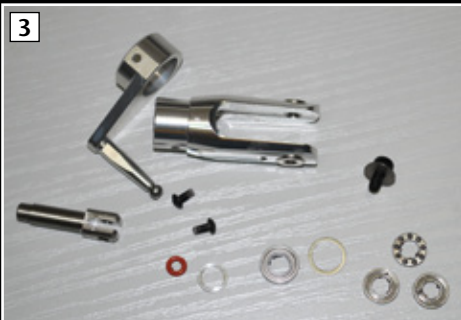
3 Die Einzelkomponenten einer Blatthalter-Einheit mit Blattverstellhebel, zwei Radial- und einem Drucklager, Blattlagerwelle, Distanzringen und Schrauben
