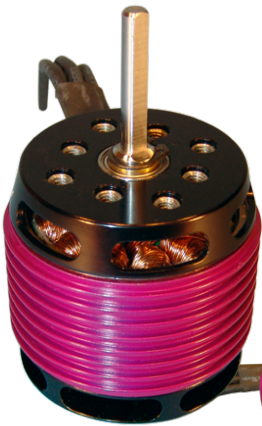
Die Rotorglocke des Turnado ist außen mit Kühlrippen versehen, die 5-mm-Motorwelle ist ab Werk über die gesamte Länge zur Ritzelbefestigung abgeflacht
