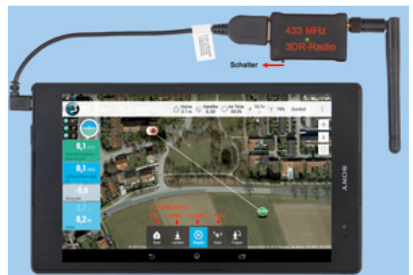
Abbildung 9: Der Kopter steht ohne Rotoren mit ausreichendem GPS-Empfang armiert auf der Fensterbank. Alle Telemetriedaten werden angezeigt. Unten einige Buttons für interessante Flugoperationen, Genaueres in Folge 4 in RC-Heli-Action 5/2016
