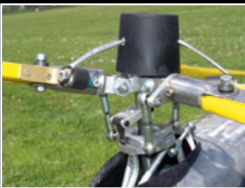
Der Dreiblattrotor ist mit Schlaggelenken ausgestattet. Auch die Anlenkung der Taumelscheibe erfolgt vorbildgetreu. Die Rotorblätter mit ihrem Clark-Y-Profil sind mit einem Gewicht von knapp 500 Gramm relativ schwer
