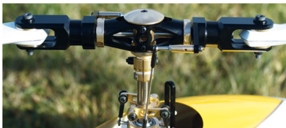
Alle Teile des Zweiblatt-Flybarless-Hauptrotorsystems sind hochpräzise aus Aluminium gefertigt und schwarz beziehungsweise gold eloxiert. Die Besonderheit ist die Delta-III-Anlenkung (Erklärung siehe im ersten Teil in RC-Heli-Action 3/2016)
