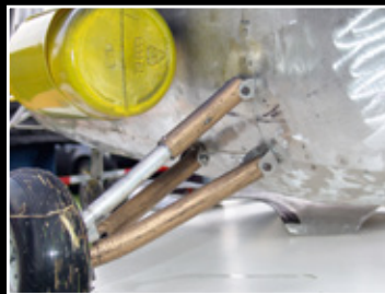
Detail des Hauptfahrwerks mit gefederten Fahrwerksbeinen. Die Tanks sitzen seitlich am Rumpfbau und fassen insgesamt 2,2 Liter Kerosin. Die Außenhaut besteht aus 1 Millimeter dünnem Aluminium-Blech
