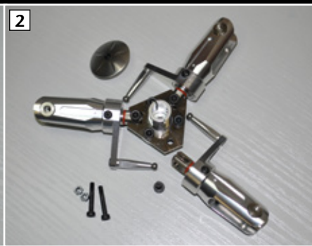
2 Unterseite der Einheit mit der geschlitzten Rotorwellen-Aufnahme. Er wird mit zwei M3-Schraufschrauben auf der Hauptrotorwelle befestigt
