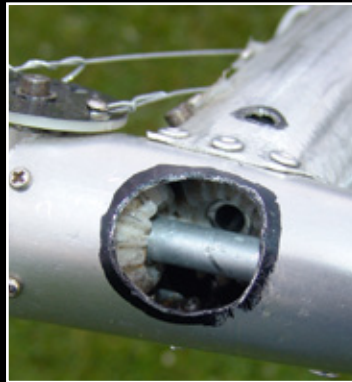
Hier erkennt man die beiden Delrin-Kegelräder des Heckgetriebes
