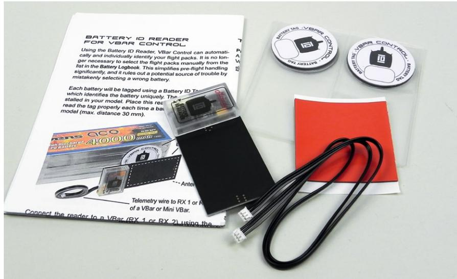
Der noch zu montierende Akku-ID-Sensor, der mittels sogenanntem RFID-Tag (das ist eine Art Transponder) die Akku-Auswahl automatisiert. Die runden Battery TAGs werden an den LiPo-Akkus befestigt
