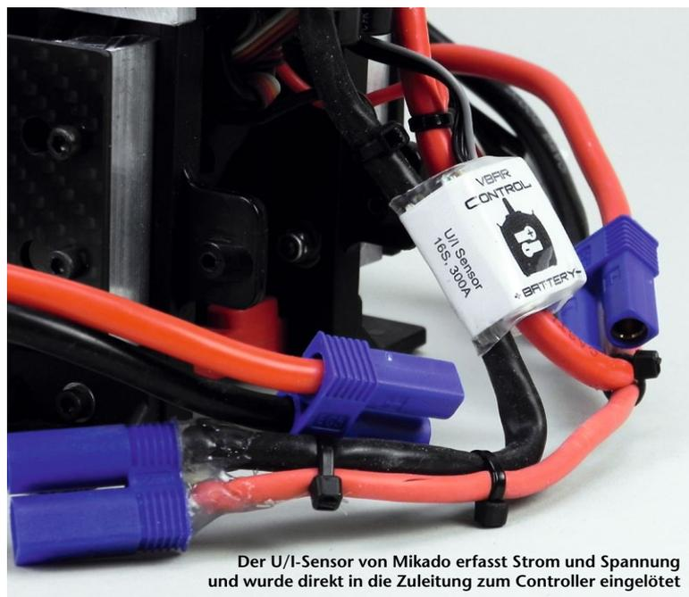
Der U/I-Sensor von Mikado erfasst Strom und Spannung und wurde direkt in die Zuleitung zum Controller eingelötet
