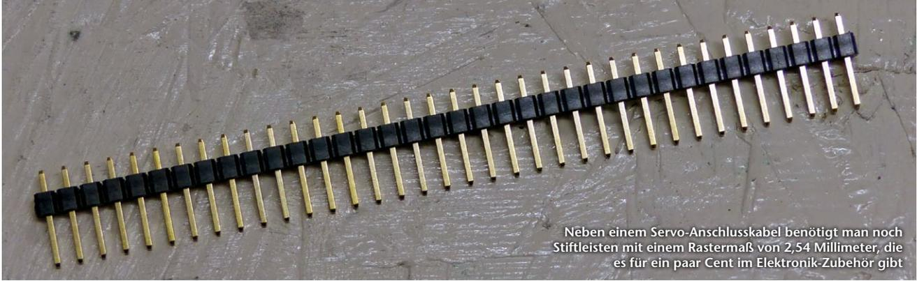
Neben einem Servo-Anschlusskabel benötigt man noch Stiftleisten mit einem Rastermaß von 2,54 Millimeter, die es für ein paar Cent im Elektronik-Zubehör gibt
