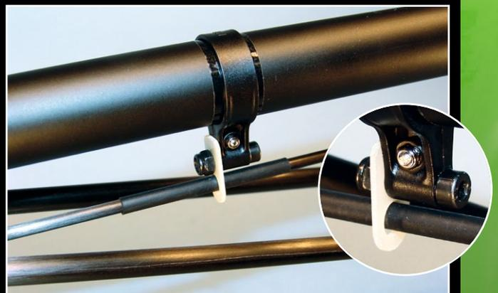
Für die zu kurze Führungsschelle am Heckrohr wurde eine kleine Verlängerung gebaut, die – direkt mit dem Original verschraubt – den notwendigen Abstand schafft. So läuft die CFK-Schubstange ohne Vorspannung parallel zum Heckausleger und praktisch reibungsfrei nach hinten
