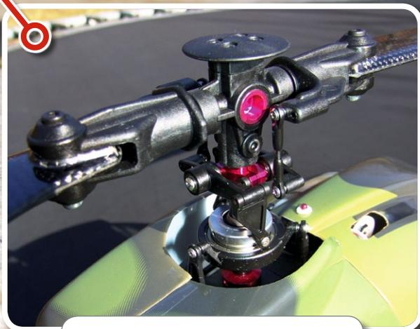
Das Zweiblatt-Hauptrotorsystem des Raptor E300 MD besitzt ein Zentralstück und Blatthalter aus Kunststoff sowie einen konventionellen Scheren-Pitchkompensator
