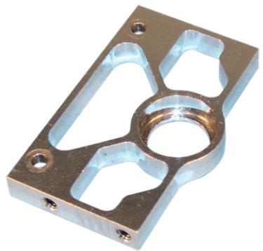
Die Einzelteile der neuen Gegenlagerplatte. Das selbst angefertigte Drehteil wird in die ehemalige Lagerschale eingepresst
