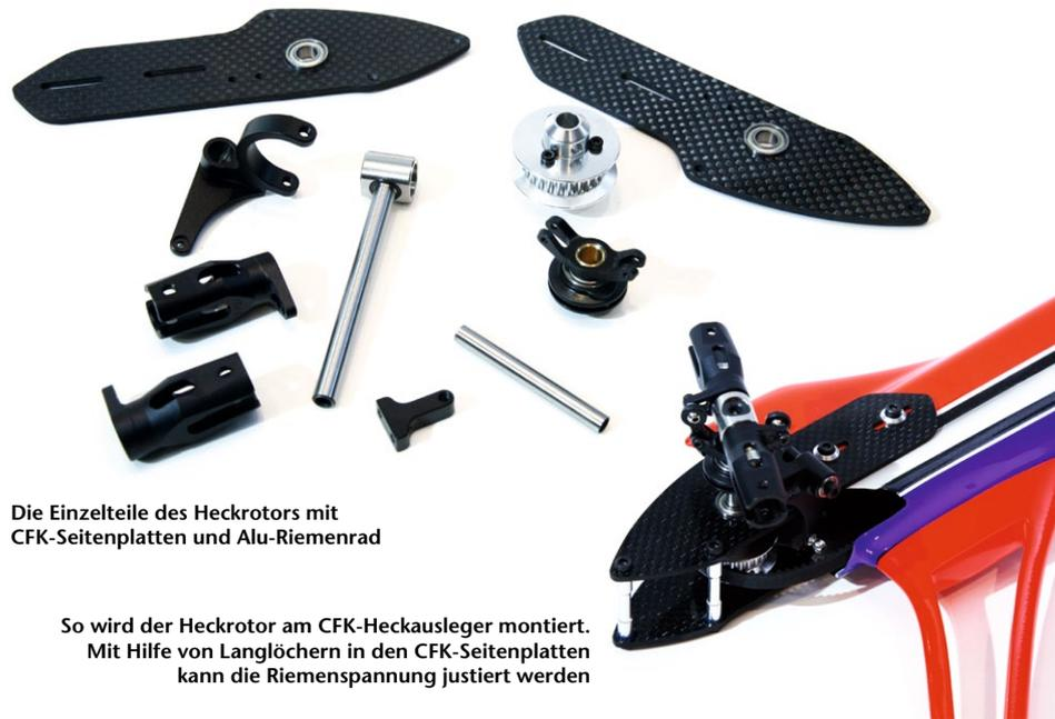
Die Einzelteile des Heckrotors mit CFK-Seitenplatten und Alu-Riemenrad
