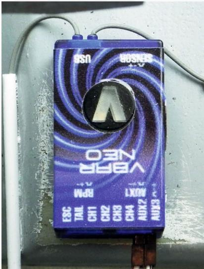
VBar NEO Slave im hinteren Bereich des Mechanik-Podestes. Der Receiver ist über die „Interbus“-Verbindung mit dem NEO Master verbunden, um bestmögliche Empfangsverhältnisse zu erzielen
