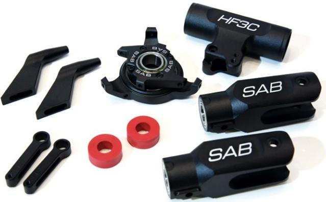
Die mattschwarzen Einzelteile des HF3C-Hauptrotorsystems, das in Zusammenarbeit mit Ennio Graber entwickelt wurde
