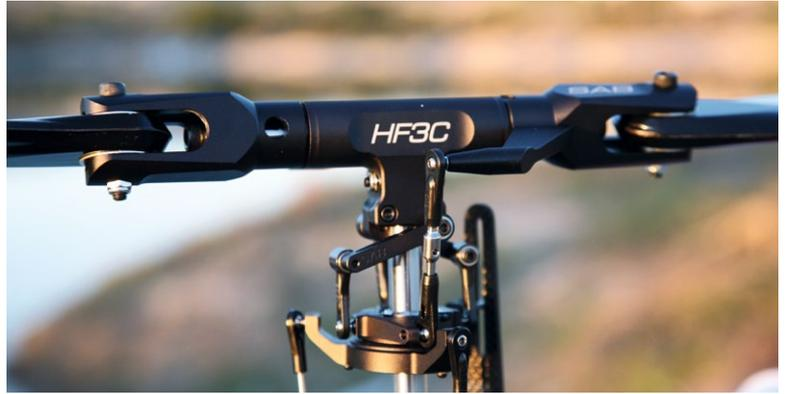
Fertig montierte Einheit. Die Anlenkpunkt der Blattverstellarme liegt relativ weit außen, um den Hebelarm zu verlängern
