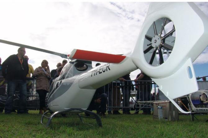
Der achtblättrige Fenestron der EC 120 besitzt 60 Millimeter lange Heckrotorblätter. Der Gesamtdurchmesser beträgt 180 Millimeter
