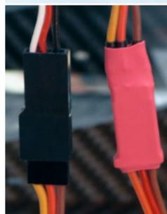
Zuletzt wird die Verbindung mit einem großen Schrumpfschlauch eingeschumpft (rechts im Bild), um sie mechanisch gegen Ausstecken zu schützen. Daneben zum Größenvergleich ein Standard-Exemplar
