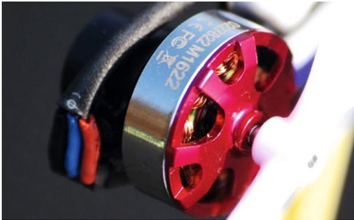
Auch am Heckrotor arbeitet ein kräftiger BL-Außenläufer, der gut gekühlt wird
