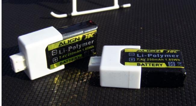
Der mit XH-Balanceranschluss versehene 2s-LiPo hat eine Kapazität von 250 Milliamperestunden und wird ...
