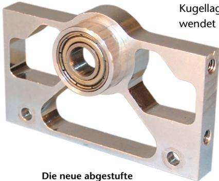
Die neue abgestufte Gegenlagerplatte. Der Bund der früheren Lagerschale dient als Tiefenanschlag für das Drehteil
