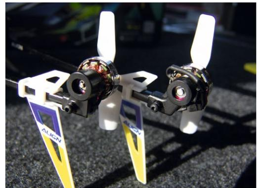
Die Heckmotor-Halterung des „X“ (rechts im Bild) ist schräg konstruiert, beim DFC gerade
