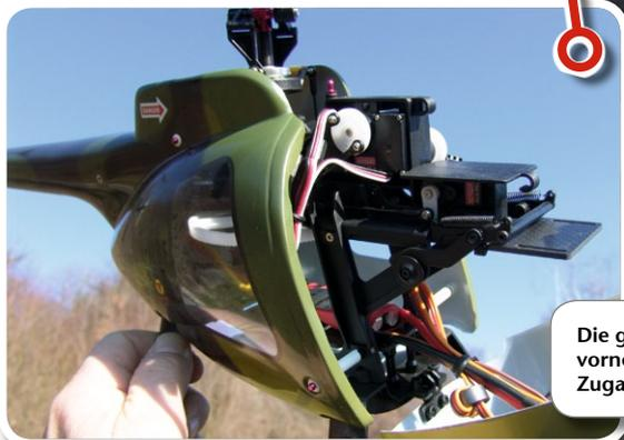
Die große Kabinenhaube lässt sich nach vorne klappen, womit ungehindert Zugang zur Mechanik ermöglicht wird
