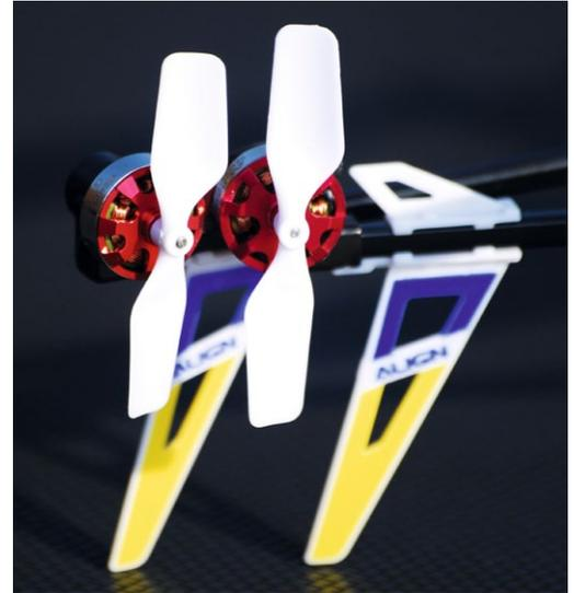
Heckrotoren im Vergleich. Der T-Rex 150 X (rechts) ist größer im Durchmesser und besitzt einen stärkeren Außenläufer als die DFC-Version
