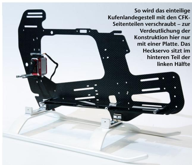
So wird das einteilige Kufenlandegestell mit den CFK-Seitenteilen verschraubt – zur Verdeutlichung der Konstruktion hier nur mit einer Platte. Das Heckservo sitzt im hinteren Teil der linken Hälfte
