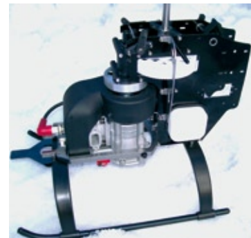
Die Seitenansicht der teilmontierten Mechanik verdeutlicht den klar strukturierten Aufbau. Der in Flugrichtung angeordnete Zylinderkopf des auf der Grundplatte befestigten Motors dient für optimale Gewichtsverteilung
