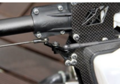
Die Heckrohrlagerung und der Umlenkhebel der Heckenlenkung. Das Heckservo sitzt vorne im Vorbau
