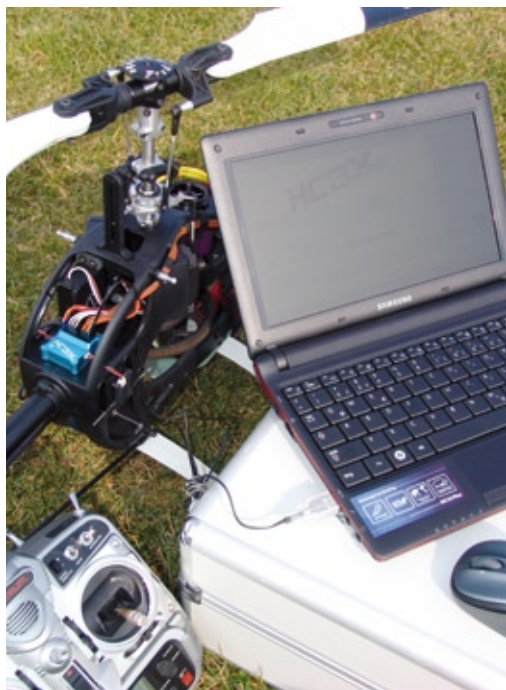
Ein PC ist zur Erstinbetriebnahme des HC3-Xbase zwingend notwendig. Grundlegende Einstellungen auf dem Flugfeld funktionieren aber vom Sender aus. Der Feinschliff muss dann wieder mit dem Rechner gemacht werden
