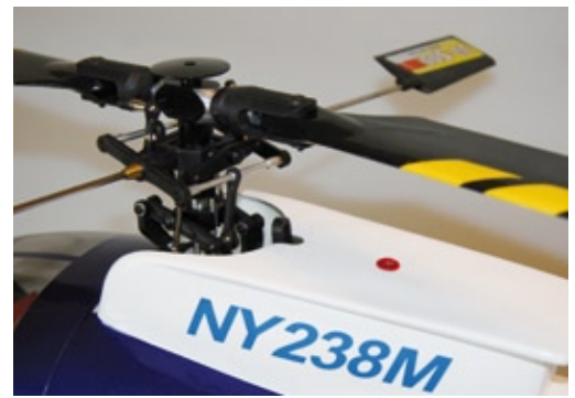
In der Domverkleidung muss für die Taumelscheibenführung eine entsprechende Ausfräsung des Rumpfs vorgenommen werden
