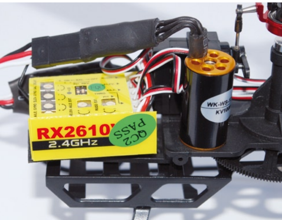
An der Bordelektronik lassen sich die Empfindlichkeiten der drei Gyros, die Größen der Servoausschläge und die beiden im Text erwähnten unterschiedlichen Flugmodi einstellen
