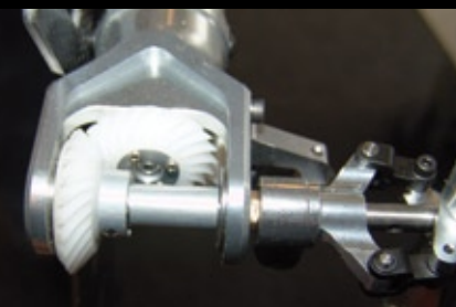
Änderungen am neuen Thunder Tiger Raptor 100 G4: Die Rotorwellen-Lagerböcke wurde X-förmig ausgeführt, um das Mastmoment besser ins Chassis einleiten zu können
