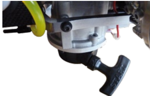
Die von Kaisermodellbau als Tuningzubehör erhältliche Trägerplatte passt optimal zum Motor und sieht viel gefälliger aus als das Originalteil. Außerdem erlaubt sie die Verwendung des abnehmbaren Seilzugstartersystems des G20. Das spart insgesamt etwa 160 Gramm Gewicht
