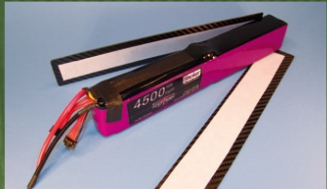
... und die beiden entgrateten und abgerundeten (!) CFK-Platten können mit doppelseitigem Klebeband aufgesetzt werden
