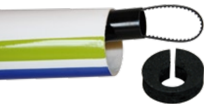
Das im Heckausleger befindliche, originale E-Rix-Heckrohr inklusive Zahnriemen. Zur vibrations sicheren Arretierung wird das Heckrohr mit einem Schaumstoffspant innerhalb des Heckauslegers in Position gehalten
