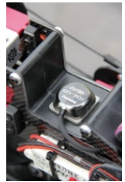
Der Sensor des Gyro-Systems ist so klein, dass man ihn von weitem kaum im Vorbau erkennen kann
