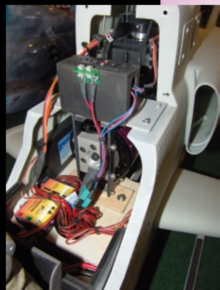
Blick in die Cobra mit der speziellen Elektro-Mechanik XL von Heli-Factory
