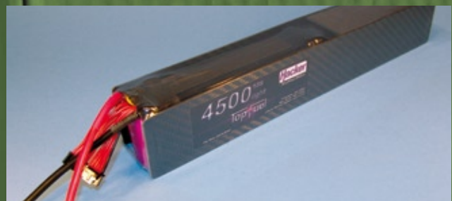
Neu eingeschrumpft, müssen nur noch die Steckverbinder an Plus- und Minuspol angelötet werden
