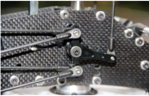
Die Push-Pull-Umlenkhebel des linken Rollservos (Vordergrund), auf gleicher Welle sitzt dahinter der Nickhebel
