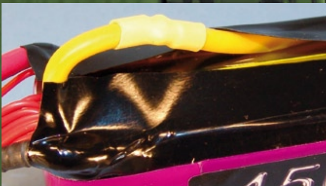
... mit einem Schrumpfschlauchabschnitt isoliert (wichtig!)
