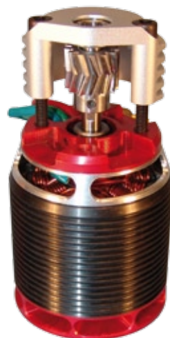
Das Motorgegenlager von Mikado. Es fängt die Radialkräfte des Ritzels durch ein zusätzliches Kugellager ab und verhindert so das Wegbiegen der Motorwelle vom Hauptzahnrad
