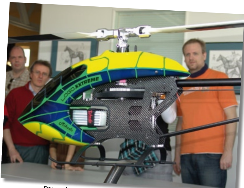
Das markante Carbon-Chassis. Deutlich zu erkennen das pfeilverzahnte Hauptzahnrad, darüber das Zahnriemenrad für den Heckabtrieb. Der Antrieb des Heckrotors selbst erfolgt über Starrwelle
