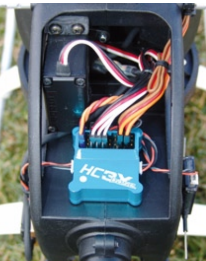
Das HC3-Xbase im Heck des LOGO 500-3D. Durch seine minimalen Abmessungen passt es perfekt. Die Flug-Performance ist top. Die Speisung erfolgt direkt durch zwei Spektrum DSM2-Satelliten
