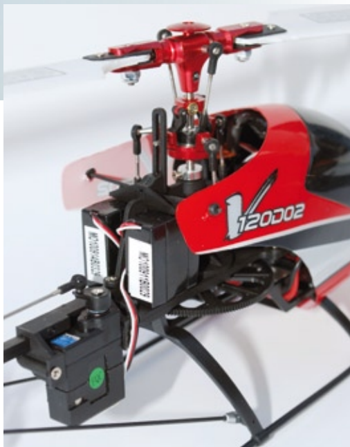
An dem winzigen V120D02 wirken selbst die verbauten 3g-Servos riesig. Laut Anleitung verfügen sie über eine Stellkraft von 1,2 Newtonzentimeter
