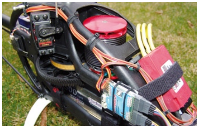
Der in seinem Antrieb optimierte LOGO 600 SE mit niedrigerer Rotordrehzahl und weniger Stromverbrauch
