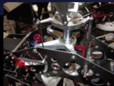
Änderungen am neuen Thunder Tiger Raptor 100 G4: Die Rotorwellen-Lagerböcke wurde X-förmig ausgeführt, um das Mastmoment besser ins Chassis einleiten zu können
