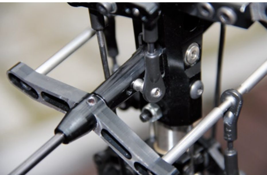
Sogar in der Wippe der Stabstangenaufhängung lässt sich der Hebelarm auswählen
