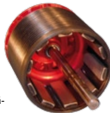
Zweimal der Rotor des PYRO 700: links die Glocke mit 10 Magnetpolen, rechts die Spezialanfertigung mit 14 Polen. Man beachte die sehr saubere Verarbeitung
