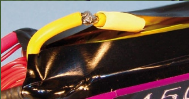
Die Kabelenden werden sauber verlötet und ...
