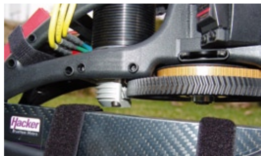
Das Mikado-Motorgegenlager ist perfekt für die Belastungen im LOGO 600 SE. Eine stabile und trotzdem sehr leichte Konstruktion (nur 21 Gramm), die nur wenig Bauraum vom Akkuschacht beansprucht
