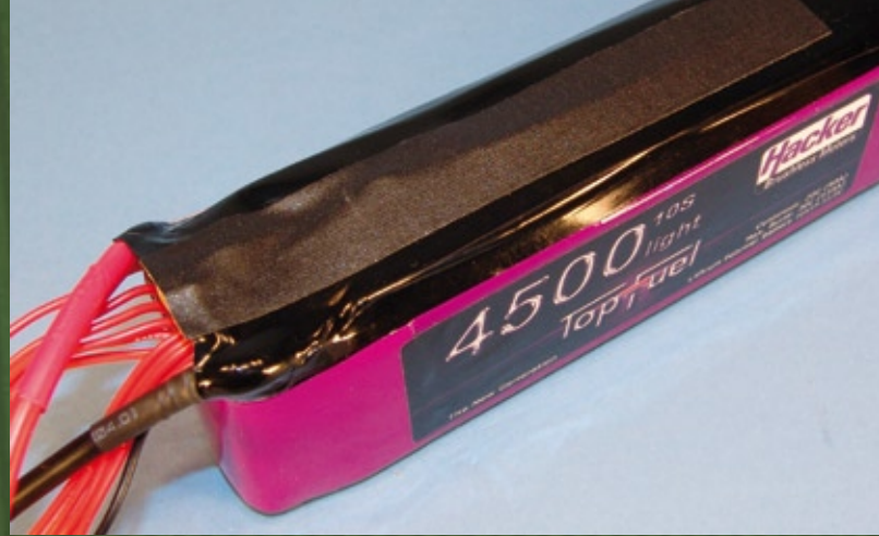
Ein Streifen schwarzes Gewebeklebeband schließt den Schnitt von oben fast unsichtbar ab ...
