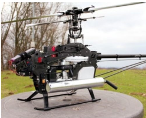
Die beiden Push-Pull-Anlenkungen des linken Roll- und Nickservos. Am Gas werkelt ein Speedservo
