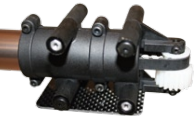
Die Heckrohraufnahme mit dem integrierten Zahnriemenrad für den Heckantrieb
