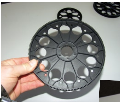
Das markante Carbon-Chassis. Deutlich zu erkennen das pfeilverzahnte Hauptzahnrad, darüber das Zahnriemenrad für den Heckabtrieb. Der Antrieb des Heckrotors selbst erfolgt über Starrwelle
