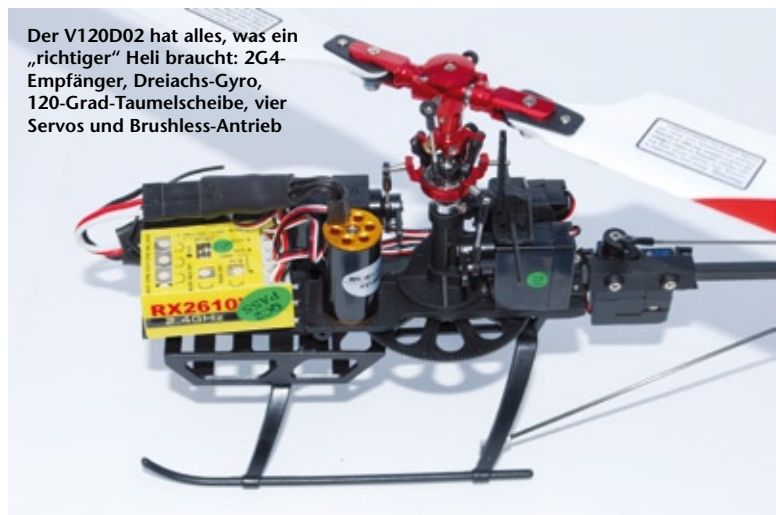
An dem winzigen V120D02 wirken selbst die verbauten 3g-Servos riesig. Laut Anleitung verfügen sie über eine Stellkraft von 1,2 Newtonzentimeter
