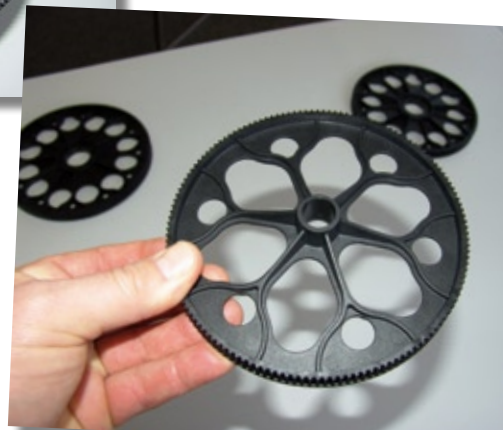
Hier das Kunststoff-Zahnriemenrad für den geräuscharmen Heckabtrieb via Zahnriemen, Kegelradgetriebe und Starrwelle
