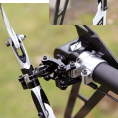
Der Heckrotor ist extrem spielfrei und sorgt in Verbindung mit dem robbe/Futaba GY 701 für sehr gute Heckperformance
