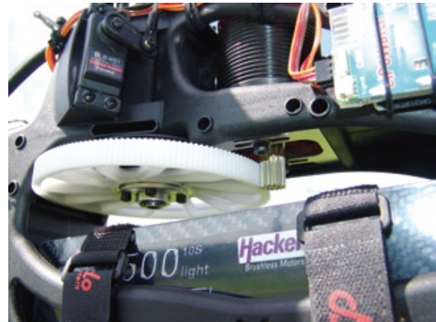
So präsentiert sich der LOGO 600 SE nach dem Umbau auf das Align-Hauptzahnrad. Man könnte fast meinen, es sei dafür gemacht
