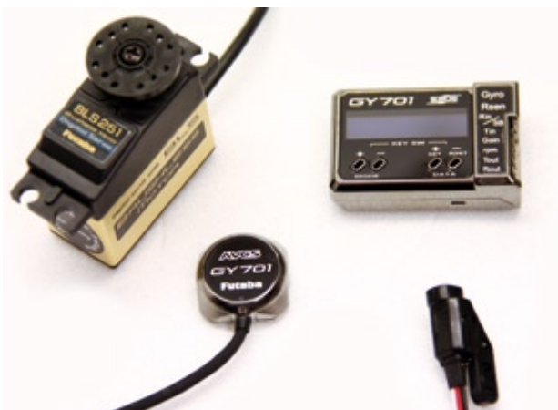
Das robbe/Futaba Gyro-System GY 701 hat serienmäßig einen integrierten Drehzahlregler für Verbrennungsmotoren. Rechts unten im Bild der dazugehörige Sensor
