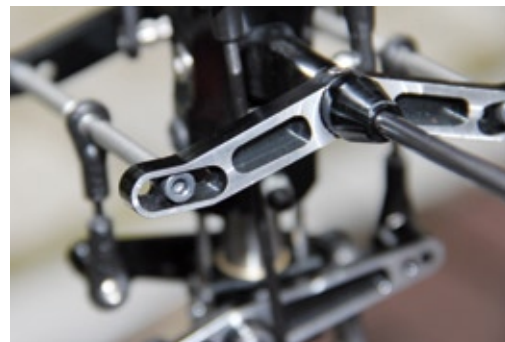
Die Steuereulisse der Stabstangen-Anlenkung verfügt über drei Anlenkgeometrien
