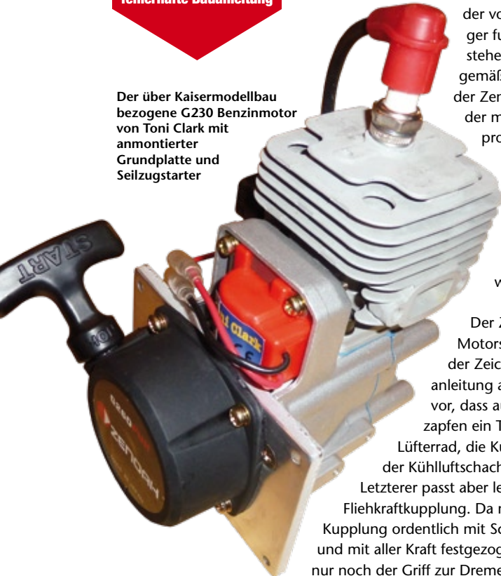
Die von Kaisermodellbau als Tuningzubehör erhältliche Trägerplatte passt optimal zum Motor und sieht viel gefälliger aus als das Originalteil. Außerdem erlaubt sie die Verwendung des abnehmbaren Seilzugstartersystems des G20. Das spart insgesamt etwa 160 Gramm Gewicht
