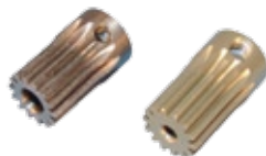
Mikado- (links) und Align-Ritzel, jeweils im Modul 0,7, im direkten Vergleich. Während das Teil aus Taiwan nur oberflächlich mit dem Hauptzahnrad kämmt, läuft das Exemplar aus Deutschland mit vollem Eingriff
