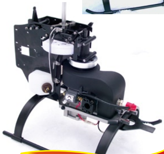
Die Seitenansicht der teilmontierten Mechanik verdeutlicht den klar strukturierten Aufbau. Der in Flugrichtung angeordnete Zylinderkopf des auf der Grundplatte befestigten Motors dient für optimale Gewichtsverteilung
