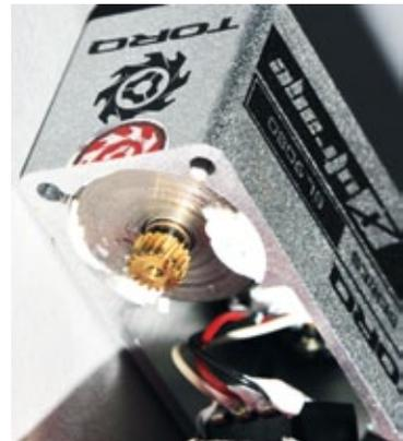
Schrägverzahntes Ritzel des Outrage BL9080. Die Elektronik ist über Wärmeleitkleber mit der Bodenplatte verbunden
