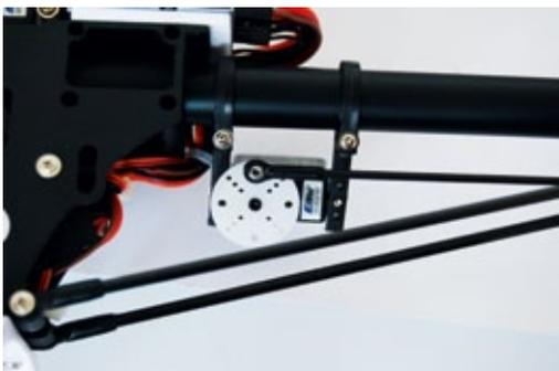
Das Heckrotorservo wurde auch schon beim 450 3D verwendet und erledigt einen hervorragenden Job
