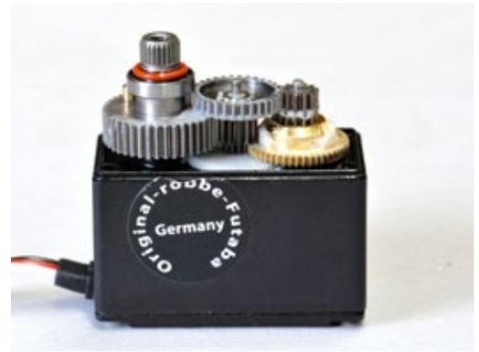
Alle robbe/Futaba HV-Testprobanden. Sämtliche Getriebe- und Platinen-Verarbeitungen (auf den beiden Bildern das BLS255) sowie Qualität ist auf bekannt hohem Futaba-Niveau
