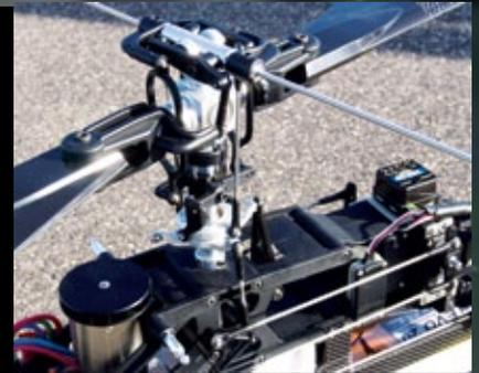
Serienmäßige Taumelscheiben-Anlenkung des Raptor E620. Benötigt wird eine elektronische Vierpunkt-Mischung mit 90 Grad, wobei der zweite Nick-Anschluss (hinten) unbenutzt bleibt
