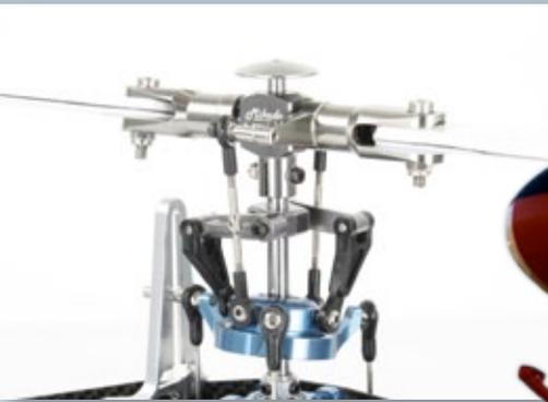
Der Flybarless-Hauptrotor des T-Rex 450, der in Verbindung mit dem microbeast eine gute Figur macht
