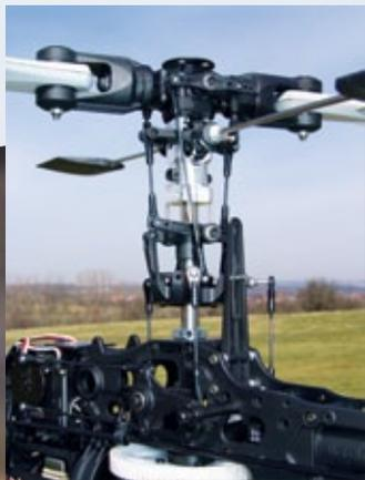
Das Hauptrotorsystem baut auf den Erfahrungen des Top 3D-Modells Turbulence D3 auf und bietet hohe Stabilität und Steuerfolgsamkeit
