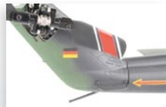
Die fertige Heckpartie. Sporn und Antenne sind auch schon montiert
