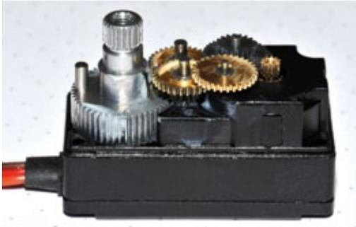
Das HBS-790 hat als besonders flach bauendes Servo ein fünfstufiges Getriebe
