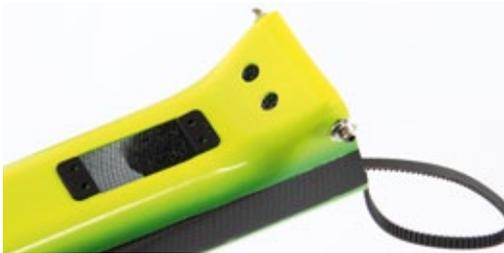
Das Heckservo befindet sich in versenkter Position an der Unterseite des Mono Booms. Die CFK-Schubstange ist mittig geführt und verläuft absolut geradlinig
