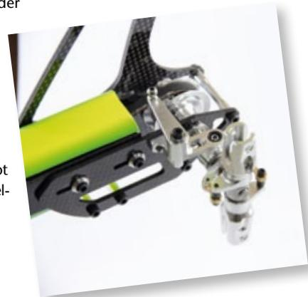
Der Heckrotor wird direkt am Ausleger angeflanscht. Das Riemenrad ist überdurchschnittlich dimensioniert und sorgt für einen großen Umschlingungsradius. Die Anlenksegmente ergeben eine spielfreie Anlenkung
