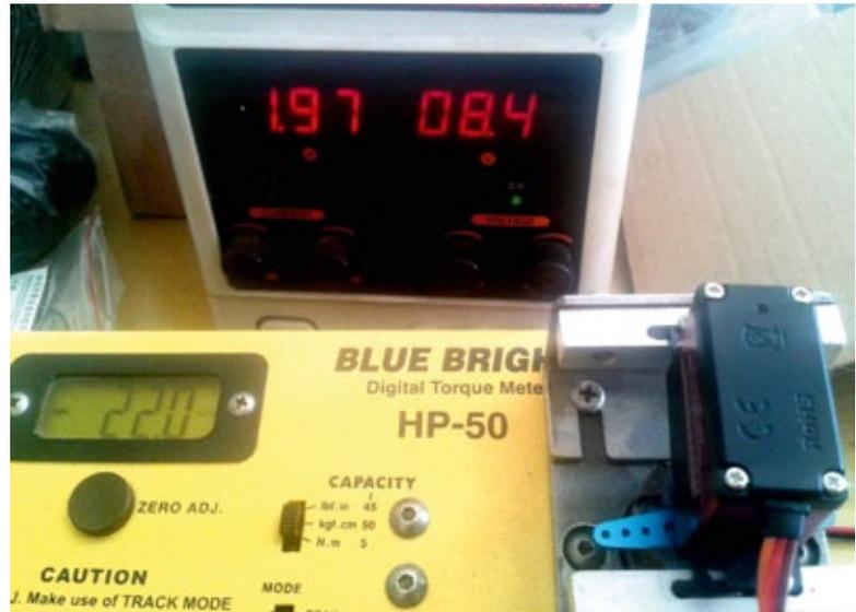
Typischer Messaufbau mit Torque-Meter nach asiatischer Methode. Vom Kupplungskreuz geht die eingeleitete Kraft über hoch untersetzte Hebelmechaniken direkt auf Drucksensoren. Strom, Spannung und Torque mit Maximalstrom = Blockierstrom können direkt abgelesen werden
