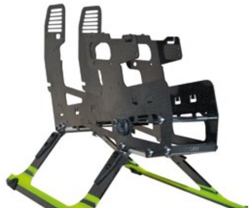
Das CFK-Grundgestell ist in wenigen Minuten fertig montiert. Es bietet zwei verschiedene Einbaupositionen für die durchgehende Akkurutsche. Ganz vorne befindet sich die Auflagefläche für den Controller. Sie besteht aus Alu und stellt somit eine erweiterte Kühlfläche dar
