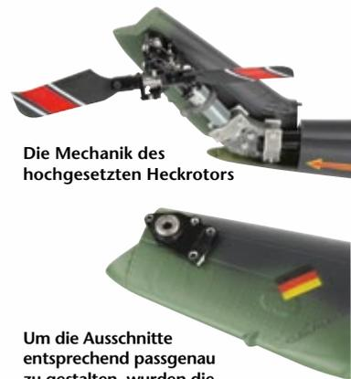
Die Mechanik des hochgesetzten Heckrotors
