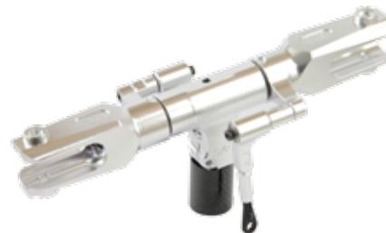
Die Spurstangen dienen gleichzeitig als Taumelscheiben-Mitnehmer. Die Ausführung mit Rechts-links-Gewinde ermöglicht eine punktgenaue Justierung des Blattspurlaufs
