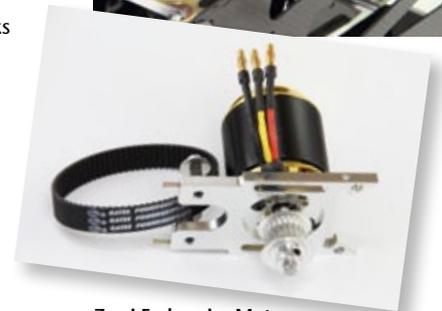
Zwei Federn im Motorträger sorgen für die nötige Riemen Spannung. Antriebsriemen einfach auflegen, danach das gesamte System von Hand durchdrehen und den Träger fixieren
