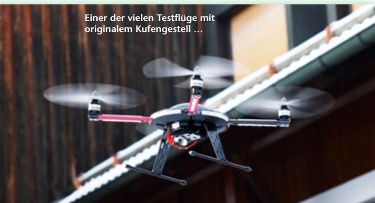
... und hier mit der verkürzten Variante des Autors, damit der Quadcopter auch mit montiertem Landegestell in den Transportkoffer passt. Zusätzliche angebrachte, farbige Bälle verbessern die Lagererkennung
