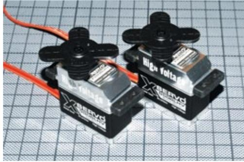
Die beiden freakware-Servos X950 und X980 BLHV. Sie sind baugleich mit den MKS HV HBL-Servos und in allen Testdaten und Parametern identisch
