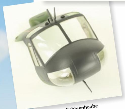
Die leichte Kabinenhaube mit eingesetzten Scheiben. Gehalten wird sie am Rumpf mit Hilfe von Verstärkungen und Magneten
