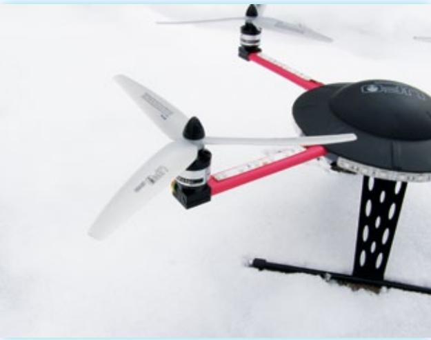
Die Befestigung der Propeller auf der Motorwelle erfolgt mit einem schicken schwarzen Spinner
