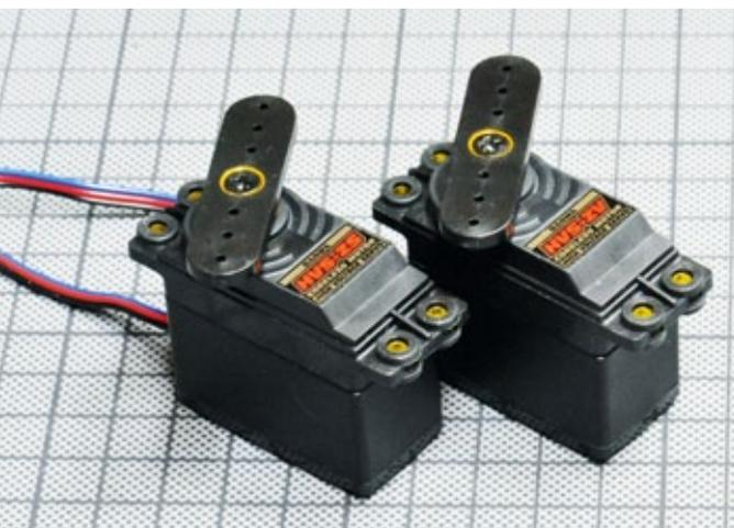
Die beiden Sanwa HVS-Servos. Die doppelstöckig aufgebaute E-Platine ist nicht zusätzlich arretiert und kann im harten Einsatz unter Vibrationsbedingungen mitschwingen. Alle Kabelanschlüsse mit Klebstoff gesichert. Die Zahnradstärken wirken im Verhältnis zur Leistungsbandbreite etwas dünn
