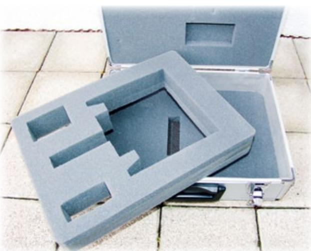
Die Schaumstoff-Einlage wurde aus jeweils 20 Millimeter (mm) starken Platten hergestellt, die vor dem Schneiden verklebt wurden. Für den Graupner-Koffer sind ideal: 20 mm Boden, 60 mm Mittelstück, 40 mm Kofferdeckel
