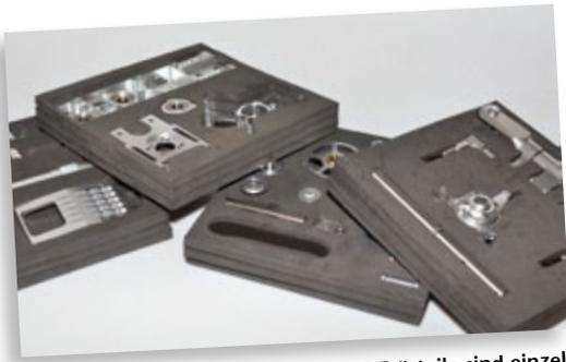
Die sehr aufwändig gefertigten CNC-Frästeile sind einzeln in Schaumstoff gebettet
