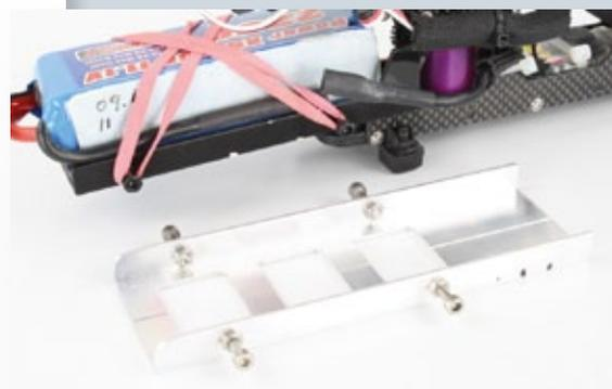
Blick auf den Eigenbau-Akkuträger, der für optimale Schwerpunktlage sorgt
