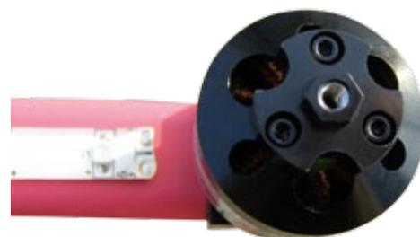
Einer der vier an den Auslegerarmen befestigte Brushless-Außenläufer mit seiner Sechskant-Nabe zur bequemen Montage der Luftschraube
