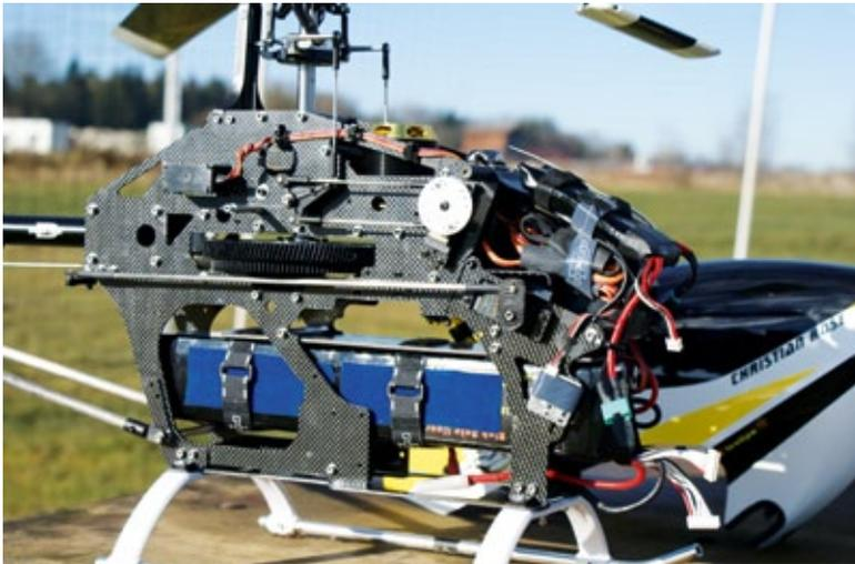
Auf der rechten Seite des Vorbaus sitzen das rechte Roll-, das Nick- und das Heckrotorservo. Gut zu erkennen ist auch der vorn angeordnete DMSS-Satellitenempfänger
