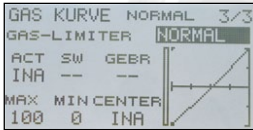
Wichtige Sicherheitsfunktion: der aktivierbare Gaslimiter, mit dem ein unbeabsichtigtes Anlaufen des Motors verhindert werden kann
