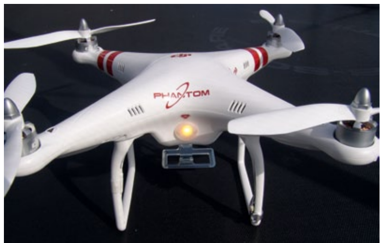
Wichtig vor dem Start: Die Initialisierung- und Aufwärmphase, die über Sechsfach-Gelbblinken angezeigt wird, muss unbedingt abgewartet werden
