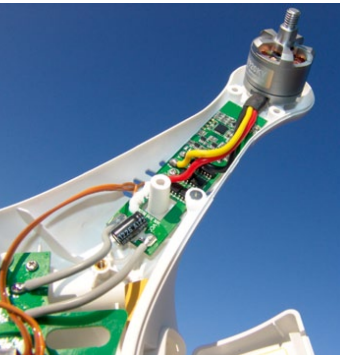
Die Controller sind jeweils in den Armen unmittelbar vor den Motoren verstaut. Die LED befinden sich auf der Unterseite der Platine
