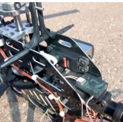
Zur Optimierung der Empfangssituation ist ein zusätzlicher Satellit verbaut. Davor das liegend im CFK-Chassis verschraubte Nick-Servo
