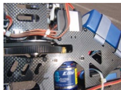
Der kraftvolle Brushlessmotor des 500 X ist mit einem 13er-Ritzel versehen (Blade 500 3D hat ein 12-Zähne Ritzel)
