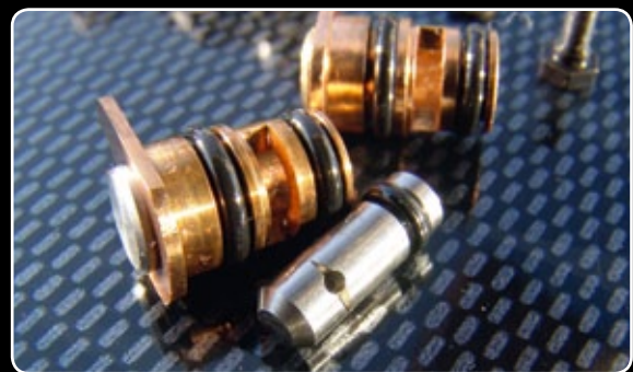
Die demontierte Steuerkulisse des Hauptdüsenstocks. Durch Verdrehen der Leerlauf-Gemischschraube verändert man die Position der Schlitz im Vergasergehäuse. O-Ringe sorgen für perfekte Abdichtung
