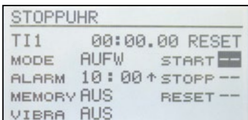
Die beiden Timer können mit einem oder mehr Gebern (auch Flugphase) beliebig gekoppelt werden
