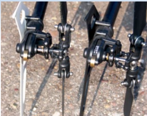
Die baugleichen Heckrotoren des Blade 500 3D und 500 X. Propeller-Momentgewichte an den Blatthaltern reduzieren die aufzubringenden Steuerkräfte, der kugelgelagerte Messingring soll ein Überspringen des Riemens verhindern
