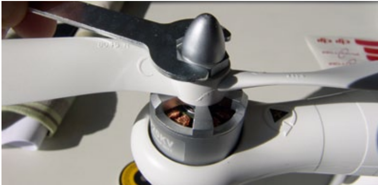
Die mit Drehrichtung markierten Luftschrauben sind in wenigen Minuten mit Hilfe von Alu-Spinnern montiert
