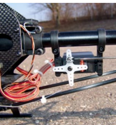
Das schnelle Spektrum-Servo SH410 High-Speed, als Cyclic-Typ deklariert, ist am Heckrohr angeflanscht
