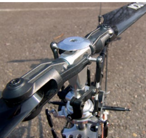
Anlenkung der Kunststoff-Blatthalter über Stahl-Kugelbolzen, die im Blattverstellarm verschraubt sind
