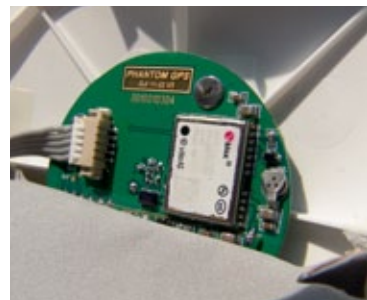
Im Deckel ist die GPS-Antenne verstaut. Das Kabel links führt zum digitalen Magnetkompass
