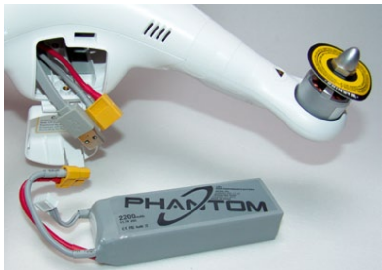
Der LiPo-Akku wird im Akkuschaft verstaut, der mit einem Deckel verschlossen wird. Hier befindet sich auch die USB-Schnittstelle zum Verbinden mit der Naza-PC-Software
