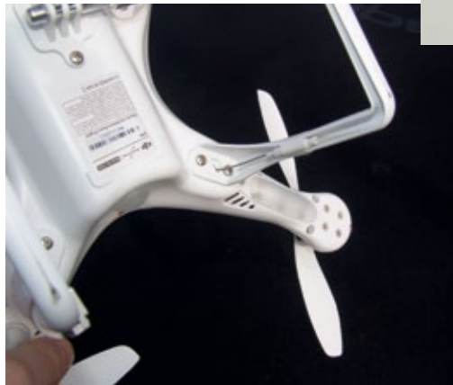
Die Empfangsantenne ist in einem Kufenbein fixiert
