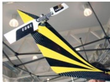
Der hochgesetzte Heckrotor, der vor Bodenberührung geschützt ist. Die Seitenflosse ist als halbsymmetrisches Profil ausgelegt, um das vom Heckrotor aufzubringende Gegendrehmoment reduzieren zu können
