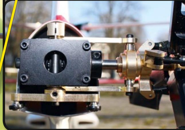
Kugellager-Orgie: Push-Pull-Anlenkung des Dreiblatt-Heckrotors mit doppelter Führung der Schiebehülse
