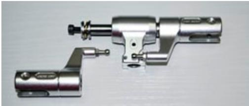
Die bereits mit Radiallagern versehenen, einteiligen Alu-Blatthalter können montiert werden. Anschließend werden die reichlich gefetteten Drucklager mit den vorgesehenen Distanzscheiben auf die Blattlagerwelle aufgesetzt
