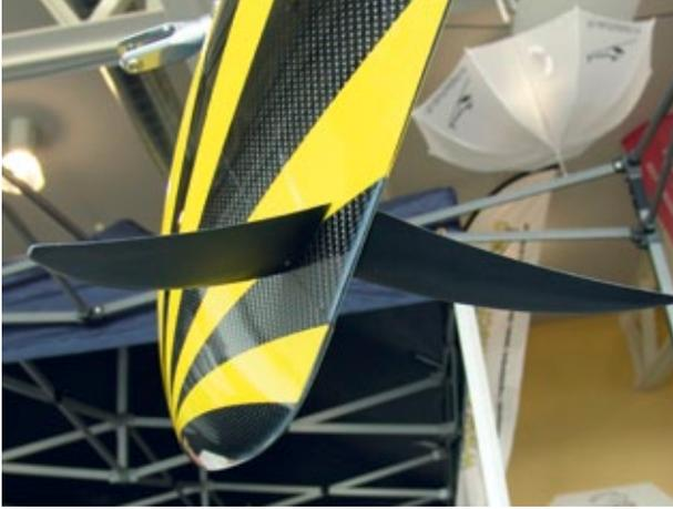
Deutlich zu erkennen sind die beiden nach unten abgewinkelten Flossen, die drehbar am Rumpf befestigt sind
