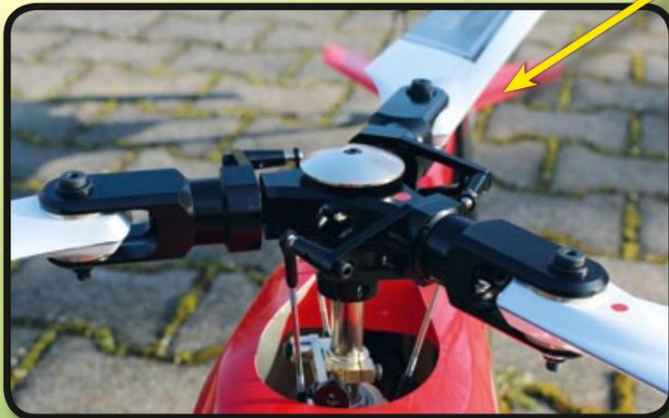
Beim Flybarless-Hauptrotorsystem kann zwischen der Zwei- oder Dreiblatt-Ausführung gewählt werden. Alle Teile sind hochpräzise aus Aluminium gefertigt und schwarz eloxiert
