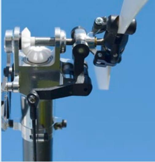
Der mit Kegelradgetriebe ausgestattete Heckrotor wird über eine Welle angetrieben. Die Anlenkung ist leider nicht ganz spielfrei
