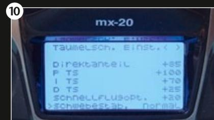
10 ... füllen sich die Taumelscheiben- und Heckrotor-Menüs mit zusätzlichen Einstellmöglichkeiten
