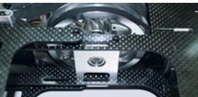
Ungewöhnlich in dieser Größenklasse: das dritte, in den CFK-Teilen verschraubte Hauptrotorwellenlager, was der Einheit enorme Stabilität verleiht
