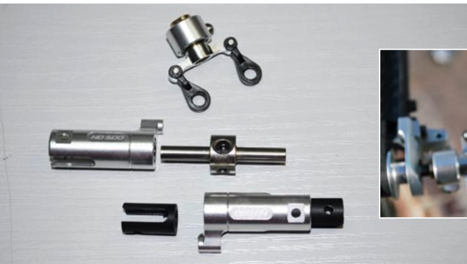
Klasse Idee: In die Blatthalter werden zwei Kunststoff-Formstücke eingeschoben und sorgen somit für einen optimalen Sitz der Heckrotorblätter
