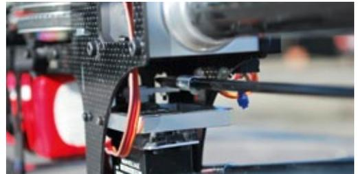
Anlenkung des Heckrotors. Auf die Kohlefaserstange ist für die Aufnahme des Gabelkopfs eine Gewinde-Aluhülse aufgeklebt
