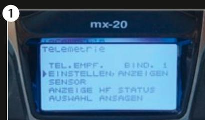
1 Über das Telemetrie-Menü des Graupner-Senders erreicht man die Gyro-Empfänger GR-24 Pro/GR-18
