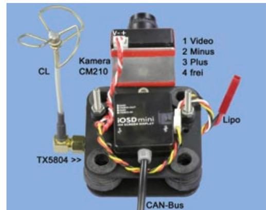
Einbau des iOSD mini und einer Kamera CM210. Das Sendemodul ist zwischen den Platten versteckt
