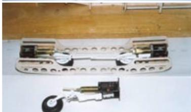
Haupt- und Bugfahrwerk werden vorbereitet und an ihren Spanten befestigt
