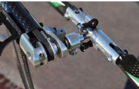
Das Heckrotor-Getriebegehäuse ist aus Alu gefräst. Das Heckriemenrad wird mit einem Quersplint auf der 5-mm-Heckrotorwelle gesichert. Stirnseitig hat die Heckrotorwelle ein Gewinde, sodass eine Madenschraube eingedreht werden kann, die den Splint arretiert
