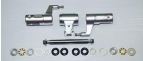
Mit diesen Teilen geht der Aufbau des Hauptrotorkopfs los. Deutlich zu erkennen ist die 8er-Blattlagerwelle, die zur Aufnahme der Drucklager an den Enden auf 6 mm abgesetzt ist
