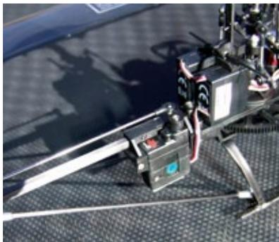
Das Heckservo ist direkt am Vierkant-Heckrohr angeflanscht
