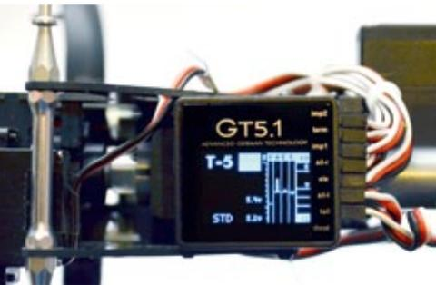
Das Flybarless-System GT5 ist mit einem winzigen Display ausgestattet, auf dem alle wichtigen Parameter angezeigt werden. Die senkrechten Balken im rechten Bereich zeigen beispielsweise die Sensorausschläge für die drei Stabilisierungsachsen an
