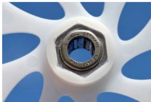
Der im Hauptzahnrad eingesetzte Freilauf „made in Germany“. Allerdings fehlen die bei Hülsenfreiläufen zwingend erforderlichen Stützlager
