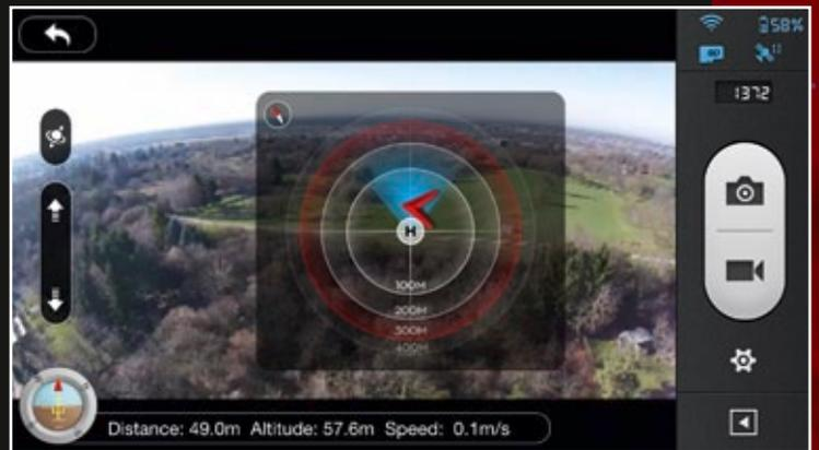
Informatives Gimmick: Berührt man das Fluglage-Symbol unten links, wird die Radar-Funktion aktiviert. Sie zeigt die momentane Himmelsrichtung und Position des Phantom 2 Vision zum Startpunkt (Home-Point) an, ebenso seine Ausrichtung. Darüber hinaus werden permanent eingeblendet, wieviel Kapazität noch im Akku ist, wieviele Satelliten momentan empfangen werden, wie stark das WiFi-Signal anliegt und vieles mehr
