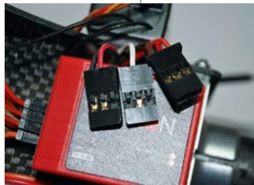
4. Übersicht: Links die beiden in Schritten 1 bis 3 gefertigten Anschlüsse, ganz rechts das andere Ende des Kabels mit allen drei im Stecker befindlichen Adern, das mit dem Kanal 6 des Graupner-Empfängers verbunden wird
