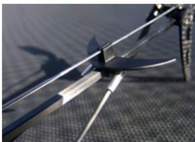
Das kleine Höhenleitwerk nimmt die beiden Heckstreben auf und fungiert auch als Führung fürs Heckgestänge
