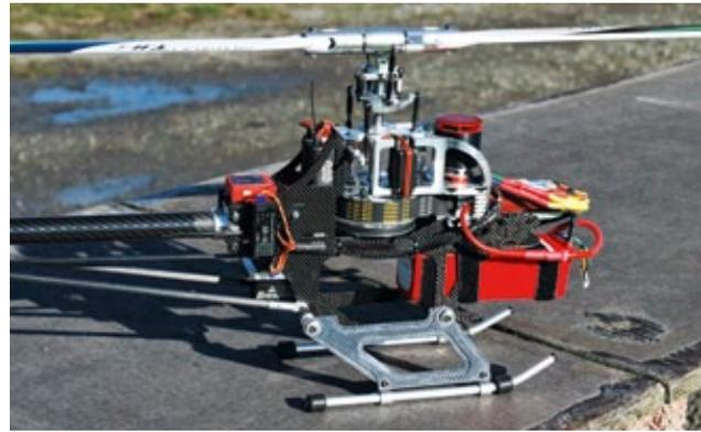
Gesamtansicht mit den besonderen Merkmalen: zentraler Aluminiumkäfig, 18 Millimeter breite Antriebsriemen sowie Heckrotorantrieb mittels Riemen
