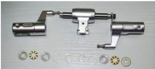
In das Zentralstück fügen sich die vier Dämpfergummis (zwei auf jeder Seite) saugend ein, die vor dem Einbau gefettet werden müssen
