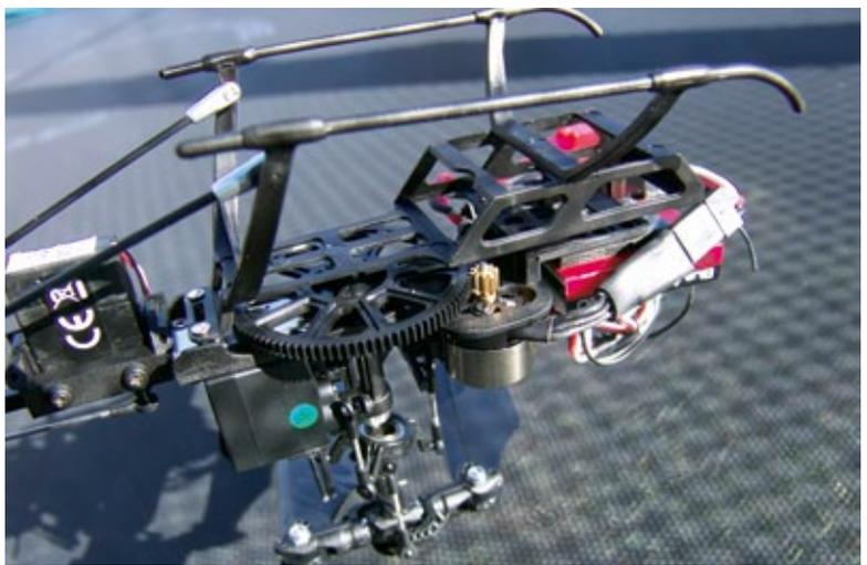
Kufengestell und Akkuschatz sind ein Spritzgussteil. Das Hauptgetriebe ist einstufig
