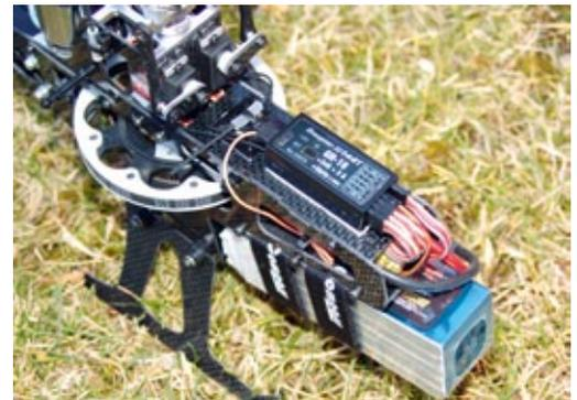
Der GR-18 ist durch seine kompakte Bauweise für kleine Hubschrauber, wie zum Beispiel den WARP 360, eine noch bessere Wahl. Die Telemetriedaten des Controllers werden über den Anschluss an seiner Rückseite eingespeist
