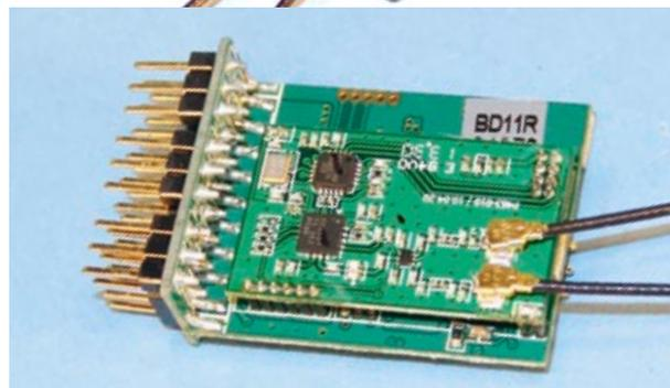
Auf zwei übereinander liegenden Platinen ist oben das UHF-Teil mit den Antennen und darunter die Signalverarbeitung mit Sensorik aufgebaut. Von innen metallisierte Gehäuse Teile dienen dem EMV-Schutz
