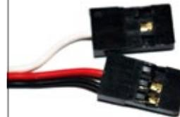
3. In das leere Kunststoff-Steckergehäuse wird das weiße Impulskabel in die mittlere Position gesteckt
