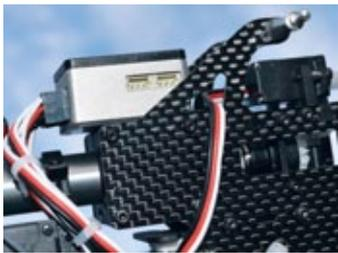
Das GT5 ist mit zwei zusätzlichen Anschlüssen für Spektrum Satelliten-Empfänger ausgestattet
