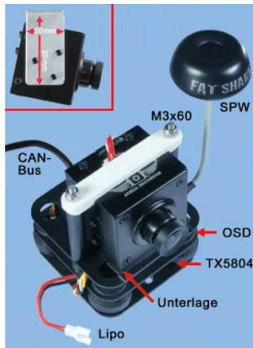
Die Flycam One 720p und das Sendemodul von ACME lassen sich bei Verzicht auf das OSD auch ohne Löten montieren
