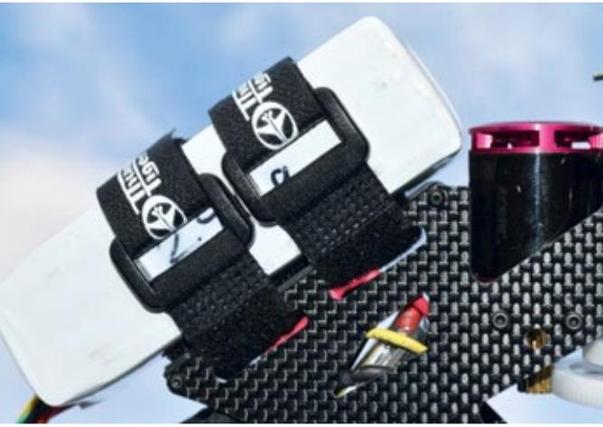
Die Akku-Befestigung erfolgt mit Klettband und zwei zusätzlichen Riemen
