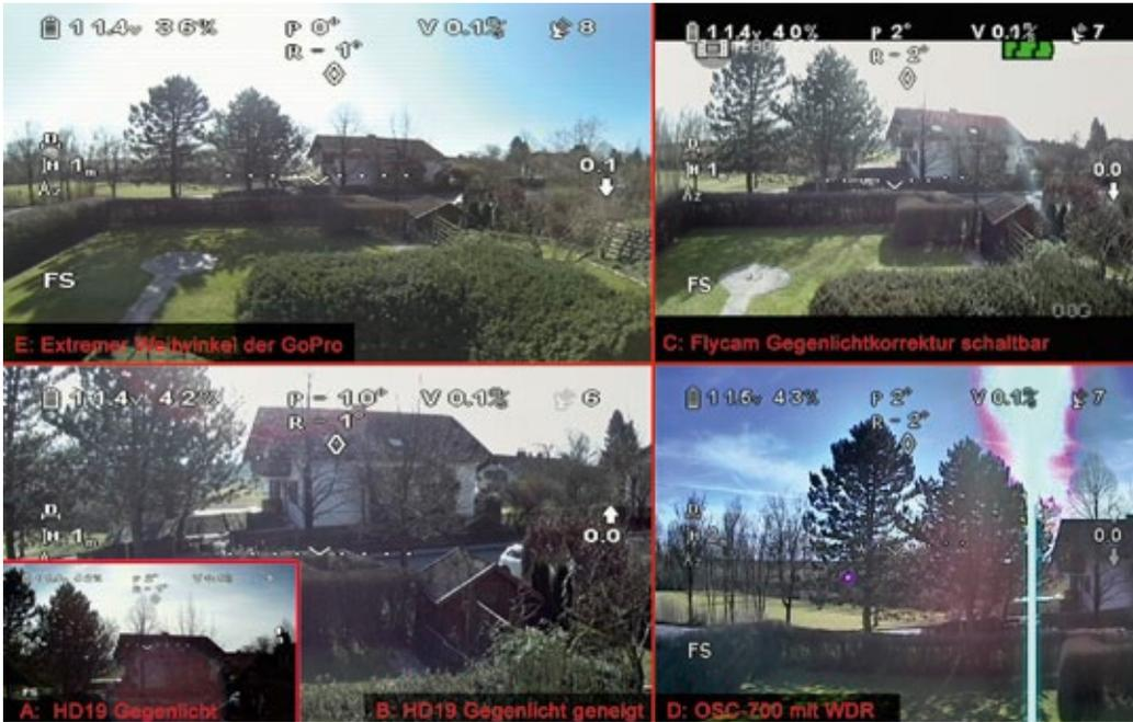
Diverse Kameras im Gegenlicht-Vergleich – alle Bilder haben die volle FPV-Strecke durchlaufen. Bild A/B zeigen die Gegenlicht-Problematik. Phänomenal die Abbildung D: Korrekte Belichtung trotz direkter Sonne im Bild
