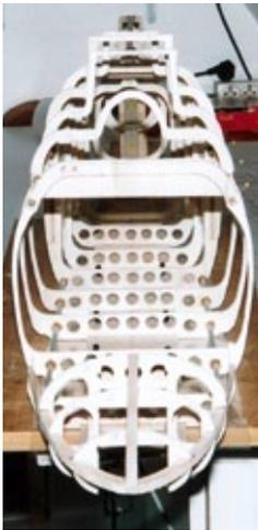
Das Rippenkonstrukt von vorne. Auf verzugsfreien Aufbau ist zu achten
