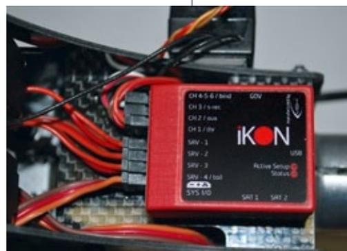
5. Der oberster Stecker in Steckplatz CH4-5-6 ist der mit dem weißen Impuls, der mittlere die Stromversorgung (rot/schwarz) in Steckplatz CH3 und der untere (CH2) der Anschluss für die Stromversorgung über das BEC des Jive-Controllers
