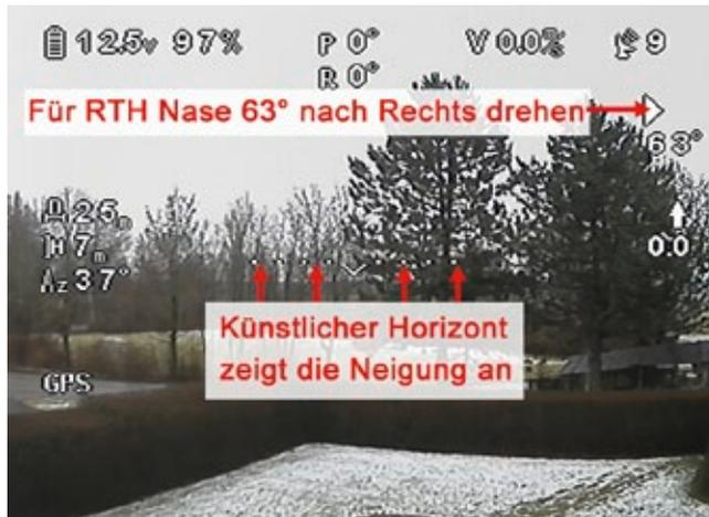
Wichtig sind die Angaben zum Drehen der Nase für den Rückflug zum Startplatz und zur erweiterten Kontrolle der Azimut
