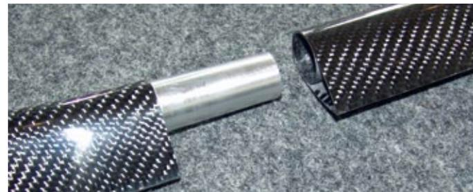
Der Heckausleger ist abnehmbar. Die Verbindung erfolgt über ein konisches Alu-Rohr
