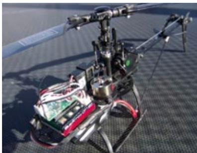
Das Nickservo sitzt neben dem asymmetrisch angeordneten Brushless-Außenläufer. Ganz vorn die FBL-Elektronik mit dem aufgesetzten S-FHSS-Empfänger
