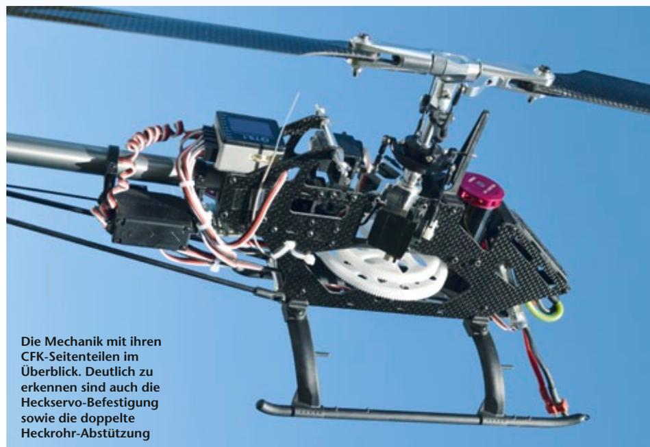
Die Mechanik mit ihren CFK-Seitenteilen im Überblick. Deutlich zu erkennen sind auch die Heckservo-Befestigung sowie die doppelte Heckrohr-Abstützung
