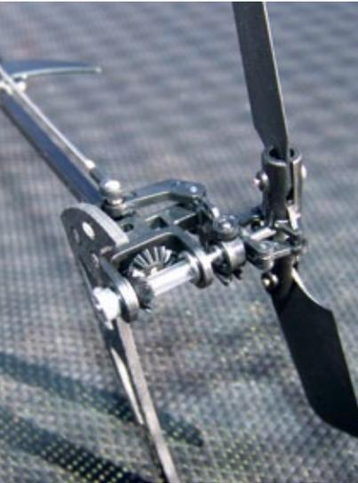
Der Heckrotor mit seinem Kunststoff-Kegelradgetriebe und der doppelt angelenkten Pitch-Schiebehülse
