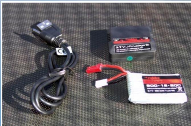
Der Antrieb des Blue Arrow CP120 erfolgt über einen 1s-LiPo mit einer Kapazität von 600 Milliamperestunden. Geladen wird über den kleinen USB-Lader
