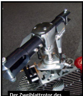
Der Zweiblattrotor des Diabolo L mit Single-Rod-Control sitzt auf einer teilhohlen Rotorwelle
