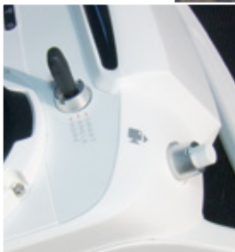
Der Dreiwegschalter für die Flugphasen, mit dem Tastschalter auf der Stirnseite wird die Filmaufnahme gestartet/gestoppt
