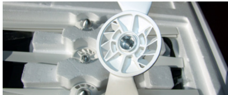
Auf den Motorwellen sitzen O-Ringe. Die Props haben eingearbeitete Lüfterschaukeln und robuste Alu-Spinnerkappen
