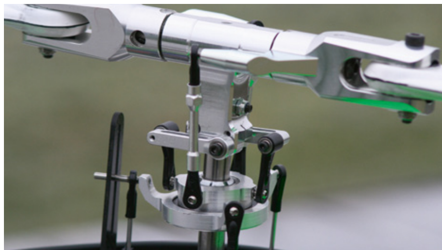
Das Goblin HPS-Hauptrotorsystem mit seinen lageneutralen Anlenkungen. Perfekte Spurlauf-Justage wird durch Steuerstangen mit Rechts-links-Gewinde ermöglicht
