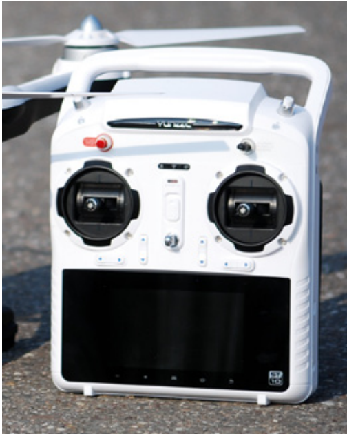
Der Sender ST10 von Yuneec besitzt ein großes Farb-Touch-Display und ist für den Multikopter-Einsatz optimiert
