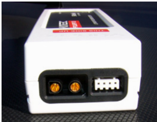
Ohne Kabelgedöns kommt der LiPo-Akku aus, der einfach bis zum Anschlag in den Akkuschaft geschoben wird
