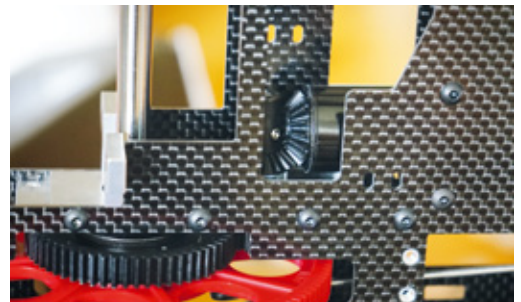
Blick auf das 90-Grad-Kegelradgetriebe für den Heckrotor-Starrantrieb
