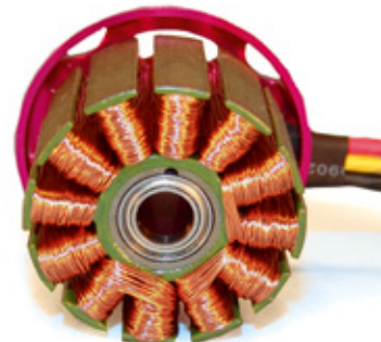
Großserienmotoren haben in der Regel aus Kostengründen eine Multifilamentwicklung aus dünnen Einzeldrähten mit relativ hohem Innenwiderstand und nicht optimalem Füllgrad. Hier passt mehr Kupfer rein!
