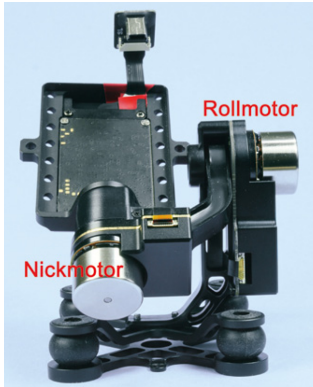
Fertig umgebautes H3-2D Gimbal. Beim alten H3-3D sieht das auch so aus
