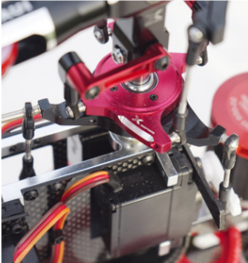
Die Dreipunkt-Anlenkung mit senkrecht angeordneten Taumelscheiben-Servos arbeitet präzise und ist spielarm
