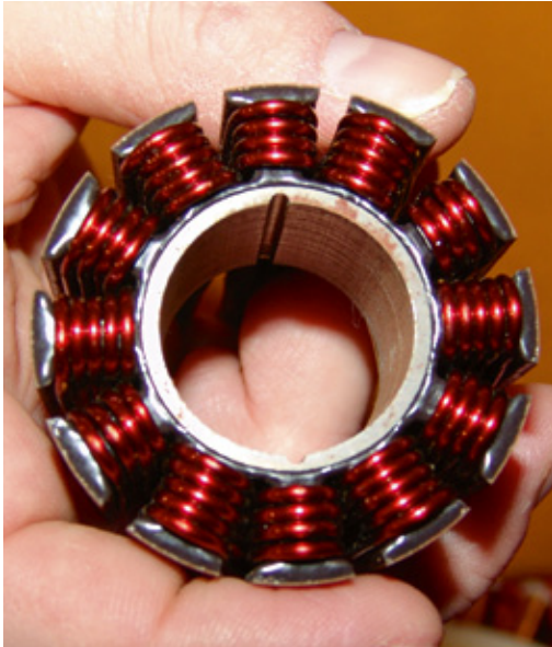
Perfekte Arbeit: So muss ein optimal verarbeiteter Stator aussehen
