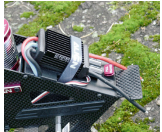
Der 70-Ampere-Align-Controller ist werkseitig vorprogrammiert. Man muss lediglich noch die Stecker für den Anschluss des Akkus anlöten
