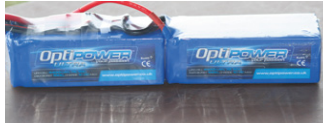
Das 14s-Setup wird mit zwei in Serie geschalteten Optipower Ultra 7s-LiPos mit einer Kapazität von 4.400 Milliamperestunden realisiert, die problemlos in den Akkuschacht passen
