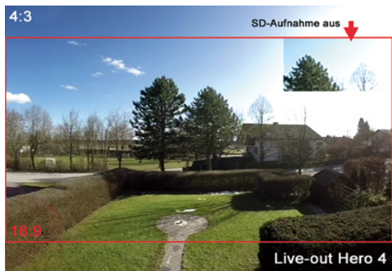
Die Hero 4 liefert nur bei mitlaufender SD-Aufnahme ein sehr scharfes, analoges FPV-Signal, je nach Einstellung in 4:3 oder 16:9
