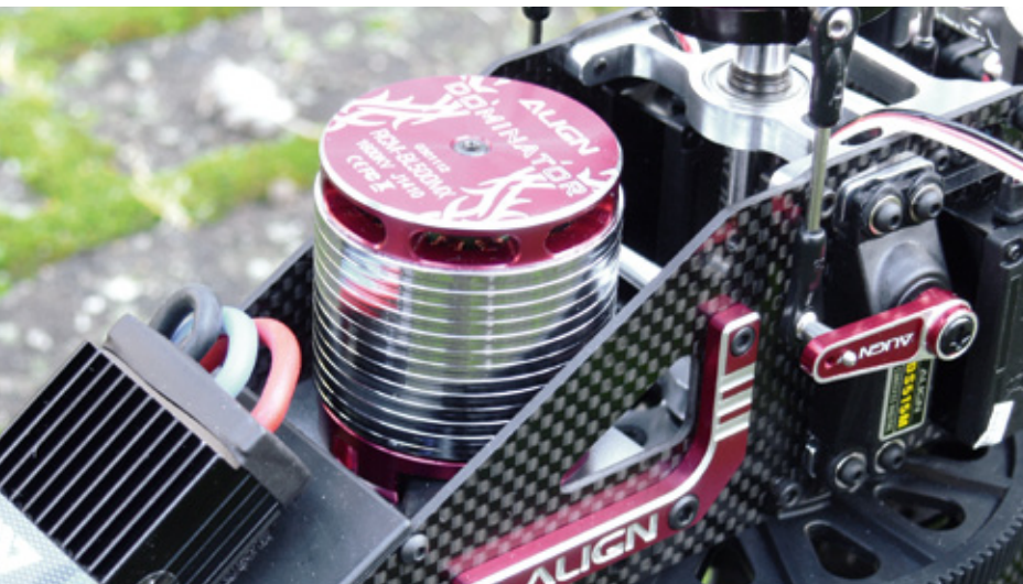
Die Taumelscheibenservos sind serienmäßig mit Alu-Abtriebshebeln ausgestattet
