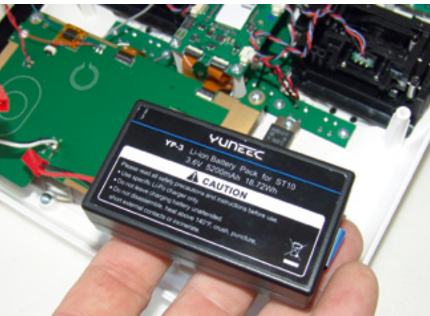
Ein Blick ins Innere des Senders attestiert beste Verarbeitung. Der 5.200er-LiPo garantiert lange Sender-Betriebszeiten
