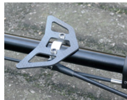
Die Heckabstützung mit der obligatorischen CFK-Finne darf natürlich auch beim 500L Dominator nicht fehlen
