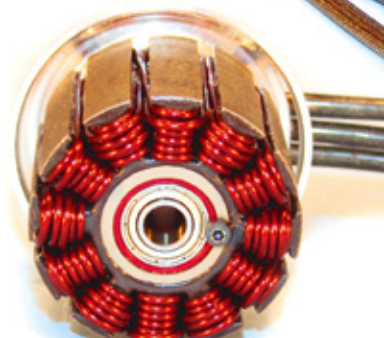
Zum Vergleich dazu ein von SlowFlyWorld von Hand auf Einzeldraht umgewickelter Motor. Die Nuten sind prall mit Kupfer gefüllt, der niedrige Innenwiderstand sorgt für hervorragende Drehzahlkonstanz unter Last
