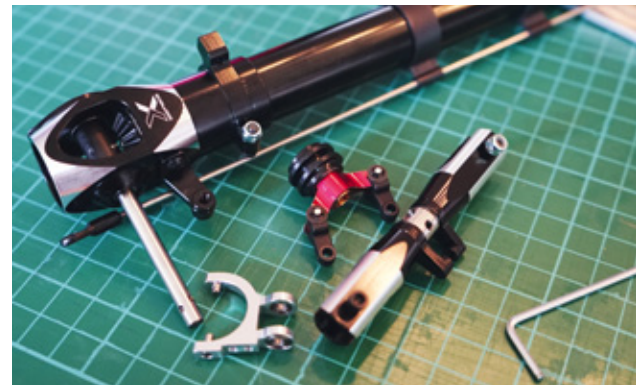
Robust verarbeitet und spielfrei – der über Starrwelle angetriebene Heckrotor
