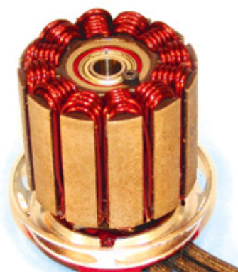
Großserienmotoren haben in der Regel aus Kostengründen eine Multifilamentwicklung aus dünnen Einzeldrähten mit relativ hohem Innenwiderstand und nicht optimalem Füllgrad. Hier passt mehr Kupfer rein!
