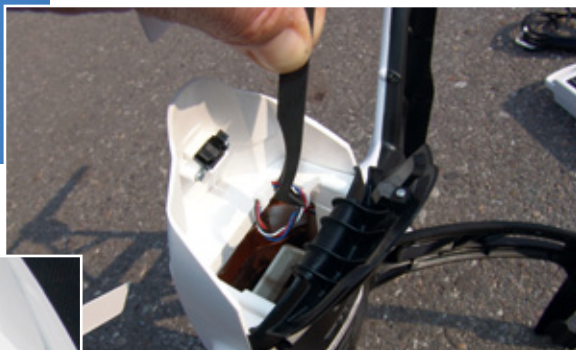
Im Akkuschaft befindet sich auch der Interface-Anschluss
