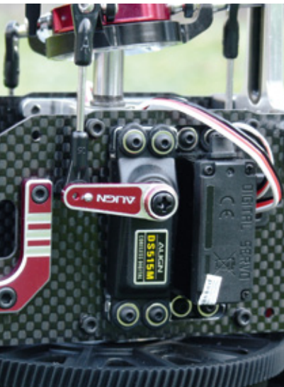
Die Taumelscheibenservos sind serienmäßig mit Alu-Abtriebshebeln ausgestattet
