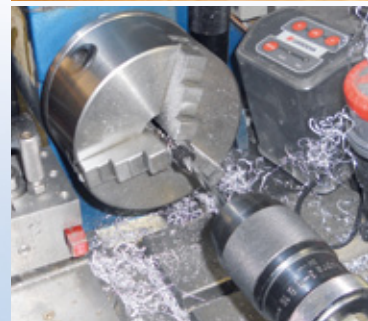
Das gesondert zu beschaffende Ritzel musste für den Pyro noch aufgebohrt werden
