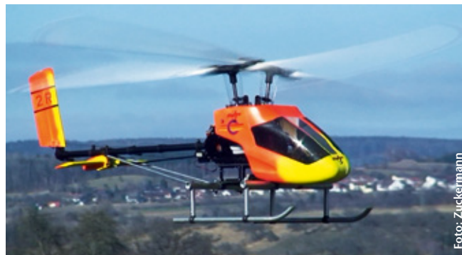
Abbildung 2: Elektro-Flettner-Testbed im Schwebeflug. Das Höhenruder ist im Flug noch um etwa 3 Grad angestellt und wurde nach der Landung korrigiert
