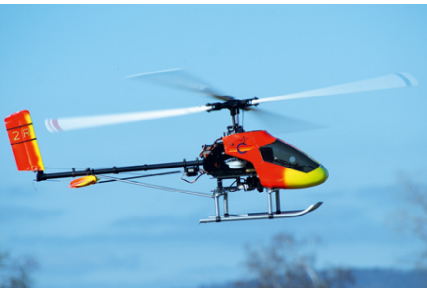
Elektro-Flettner-Testbed im horizontalen Steigflug. Das Höhenleitwerk steht bei 7° Anstellwinkel
