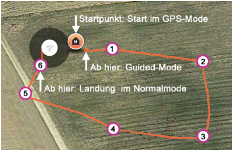
Abbildung 7: Problemlos hoverte der Kopter beim realen Test über jedem Punkt, bis ein weiteres Ziel am Tablet angetippt wurde
