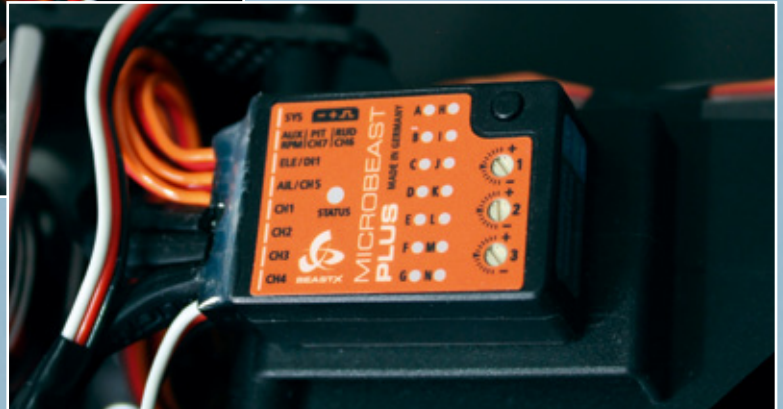
Eine Kombination aus erhöhter Taumelscheiben-Empfindlichkeit (Poti 1) und einem fast voll aufgedrehten Poti 2 (Direktanteil) sorgt bei unserem 550er-Dominator für eine unverschämt knackige 3D-Performance
