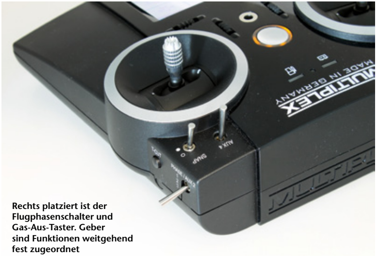
Hier erfolgt die Geberzuordnung (Beispiel Heli). Die Gas-/Pitchrichtung lässt sich leider nicht auf „Leerlauf vorne“ programmieren
