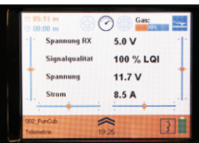
Ermittelte Telemetrie-Werte aktualisiert der Sender laufend und stellt diese sehr gut sichtbar auf dem Bildschirm dar
