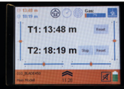
Zwei einstellbare Timer stellt die Cockpit SX bereit, beispielsweise zum Stoppen der Motorlaufzeit ab einer bestimmbarer Gasknüppelstellung
