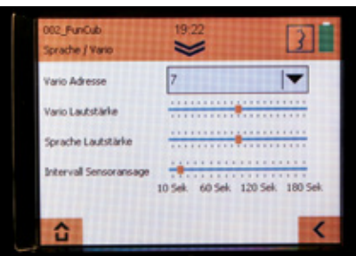
Lautstärke von Sprachansage und Vario sind getrennt einstellbar sowie der Intervall der Ansagen veränderlich
