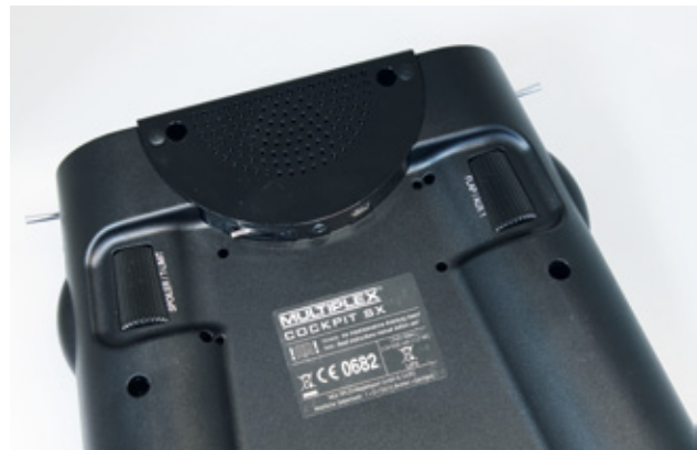
Die rückseitig integrierten Drehgeber sind recht groß geraten, sehr gut mit dem Finger erreichbar und lassen sich leicht bedienen. Eine gute Akustik bietet der Lautsprecher. Geladen wird über die Mini-USB-Buchse
