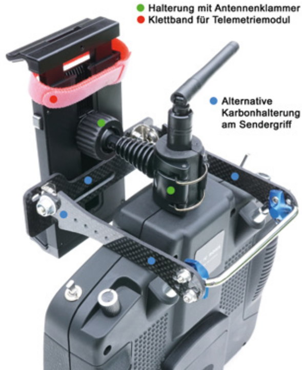
Abbildung 1: Bei stabiler Antenne wird die mit der Halterung gelieferte Gummimuffe innen passend ausgearbeitet (nicht ganz einfach), und die original Befestigung verwendet. Einfacher ist Aufkleben der Halteplatte auf die am Sendergriff befestigte blau markierte ACME FPV Halterung
