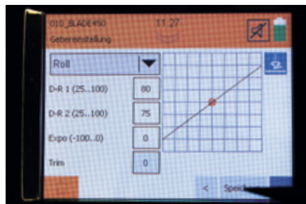
Hier können verschiedene Dual-Rate und Expo-Werte programmiert werden
