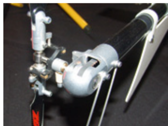
Klare Sache, dass sich der zahnriemengetriebene Heckrotor des Heli-Baby NT auch an der „richtigen“ Seite befindet
