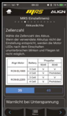
Wahl des LiPo-Akkus und Warnschwellen
