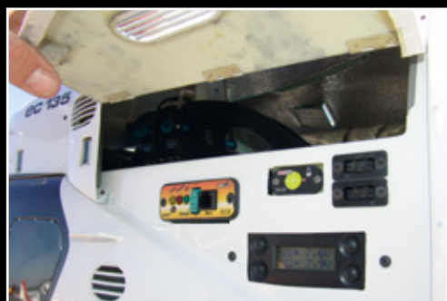
Hinter der Wartungsklappe links oben befinden sich die Bedien- und Kontroll-Elemente nebst Ladezugängen von Turbinen- und RC-Akkus
