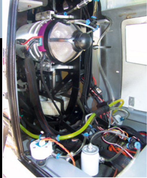
Die Vario-Turbinenmechanik mit der relativ weit oben positionierten Zweiwellen-Turbine SPT5-H der Firma JetCat
