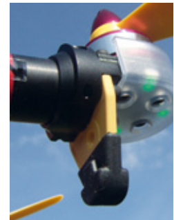
Statt eines Kufengestells gibt es gummierte Stützen an den Motoren
