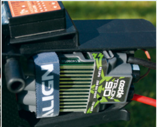
Der serienmäßige Controller Talon 90 von Castle Creations harmoniert anstandslos mit dem verbauten Außenläufermotor Align 730 MX. Bei Durchschnitts-Strömen von 70 Ampere kam es nie zu Überhitzungen (siehe Text)
