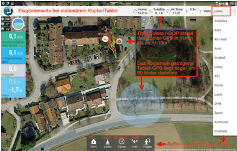
Abbildung 4: Unter ungünstigen Bedingungen kann die Anzeige speziell des Tablet-GPS sehr ungenau sein (Tablet und Kopter stehen im Bild fest am selben Ort). Daher nutzen wir Mode Folgen (Follow Me) nicht. Info über die gelisteten Modes gibt es im Internet
