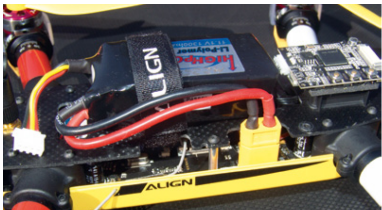
Detail der Akkuverbindung (XT60). Die Antennen-Enden des Spektrum-Receivers sind nach außen geführt
