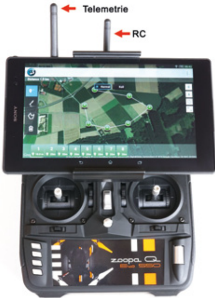
Abbildung 2: Helles Bild – Sony Xperia Z3 mit Antireflexfolie am Zoopa Sender. Das Telemetrie-Modul haben wir hinten an der Halteplatte befestigt. Die Antennen müssen in „Flughaltung“ des Senders nahezu senkrecht nach oben zeigen
