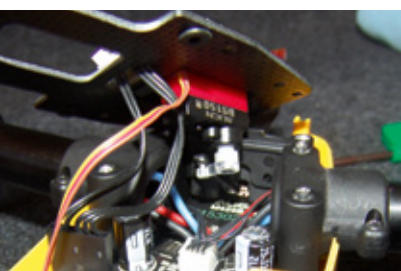
Deutlich zu erkennen – das kleine im oberen Deckel verschraubte Servo zur Verstellung des Kamerawinkels
