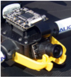
Die neigbare HD-Kamera ist über ein herausnehmbares Flachbandkabel mit dem Video-Rekorder verbunden
