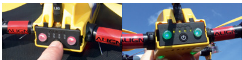
Sehr gut gelöst: Das Ein- und Ausschalten erfolgt am Akku-Management-Board, das auch über die vier LED-Balken den Ladestatus anzeigt
