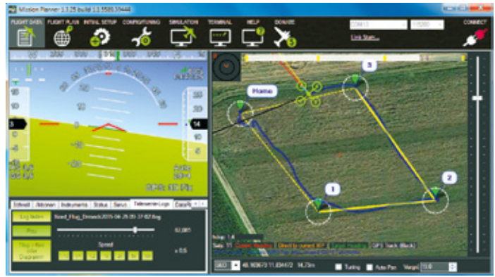
Abbildung 11: Der Kopter ist auf RTL zu Home (schwarz), Nase (rot) und WP-Kurs (orange) bleiben bei RTL so wie sie im letzten Abschnitt waren. Das PFD zeigt konstante Schräglage Roll links, weil der Kopter mit 3 m/s quer zur Nasenrichtung fliegt
