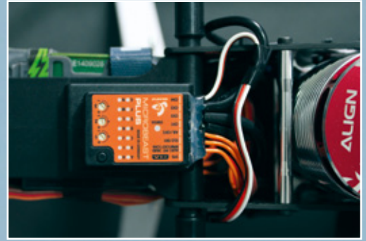
Die in der Buchsenleiste des Microbeast PLUS befindlichen Stecker wurden zusätzlich mit Kleber gegen Herausrutschen gesichert
