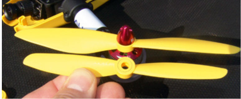
Zum Lieferumfang gehören 5- und 6-Zoll-Luftschrauben. Rechtsläufer sind mit einem schwarzen Ring markiert
