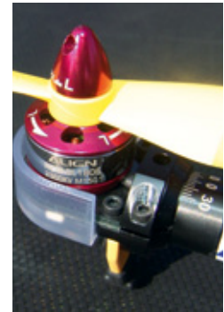
Auf Spinnerkappen und Außenläufern sind die Drehrichtungen markiert. Die Motoren lassen sich im Anstellwinkel beliebig verdrehen (Markierung)
