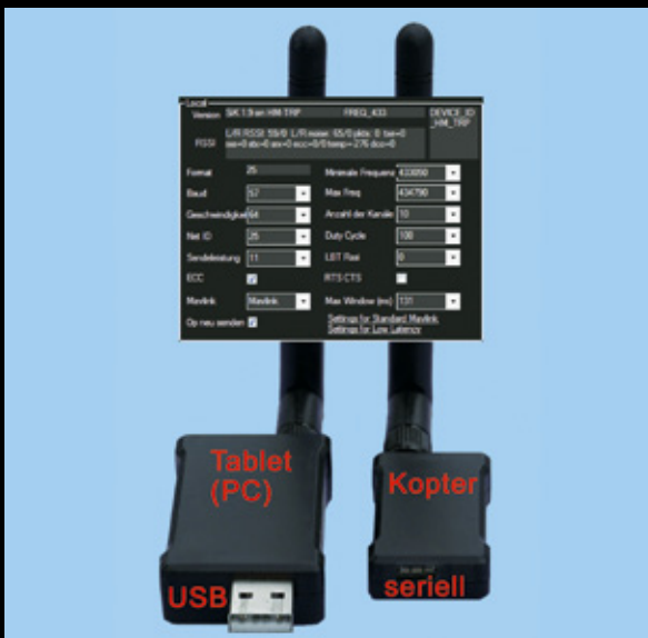
Abbildung 16: Diese Parameter wurden geliefert, unsere Module blieben damit unter 10 mW. Geschwindigkeit könnte man für noch mehr Reichweite bei etwas trägerer Reaktion bis 24 absenken
