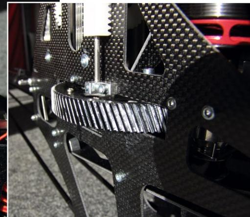
Stahlbolzen-Arretierung der Roll-Anlenkungen unten am Chassis
