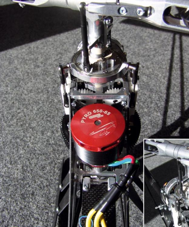
Das Chassis des TDF ist extrem torsionsstabil und steif. Hinter dem Motor erkennt man eine der beiden X-Versteifungen. Die lichte Chassis-Weite ist so bemessen, dass nicht nur Motoren der „kleine“ Pyro 650er-Größe hinein passen, sondern auch ...
