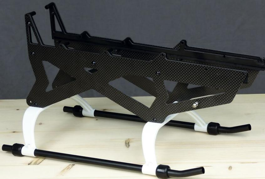
Nach nur wenigen Minuten steht bereits das untere Chassis vor dem künftigen DB7-Piloten. Es ist deutlich flacher als das des bisherigen 700er-Soxos. Eine ausgeprägte Neigung nach vorn sorgt am Heck für Bodenfreiheit
