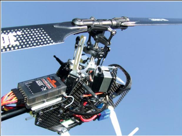
Blick auf die Dreipunkt-Taumelscheiben-Anlenkung und den Zweiblatt-Flybarless-Rotor des Blade 250 CFX
