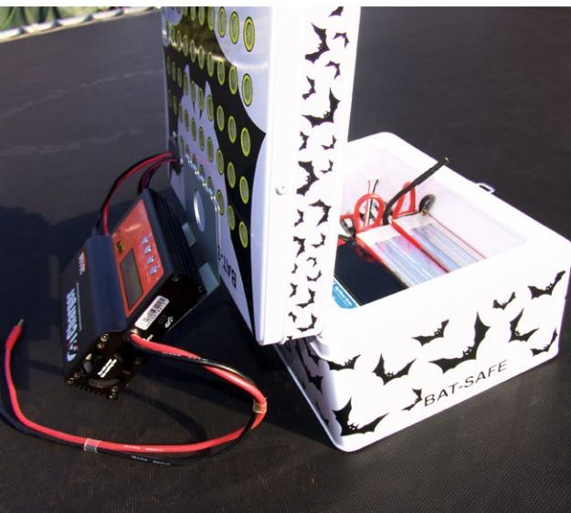
Die Konstruktion ist so ausgelegt, dass das Ladegerät beim Aufklappen des BAT-SAFE am Deckel montiert bleiben kann
