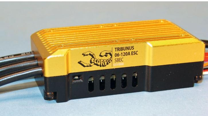
Das Gehäuse ist zweigeteilt (Metall/Kunststoff) und miteinander verschraubt. Die Leuchtdiode links neben den seitlichen Kühlöffnungen dient zur optischen Kommunikation per Morse-Alphabet
