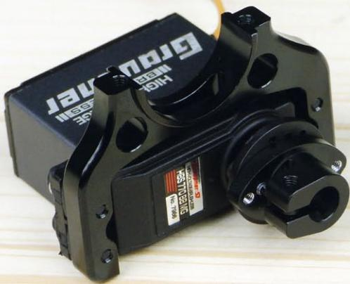
Das Heckservo mit aufgeschraubtem Adapter für den Torsionsstab. Die Gewinde im Adapter passen perfekt zu den kleinen Futaba-Scheiben
