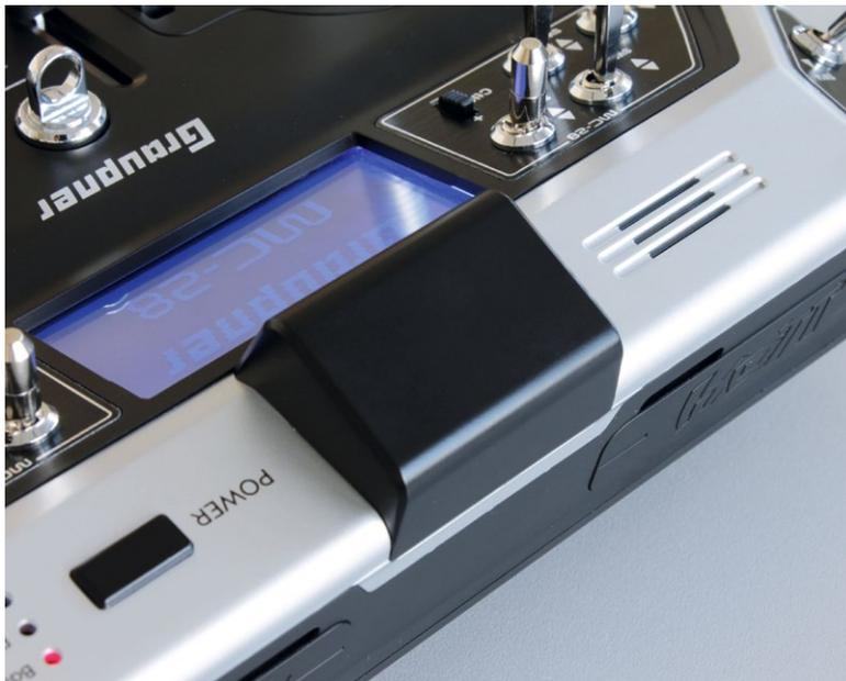
Integriert, aber nicht versteckt: Die polarisierte Patch-Antenne
