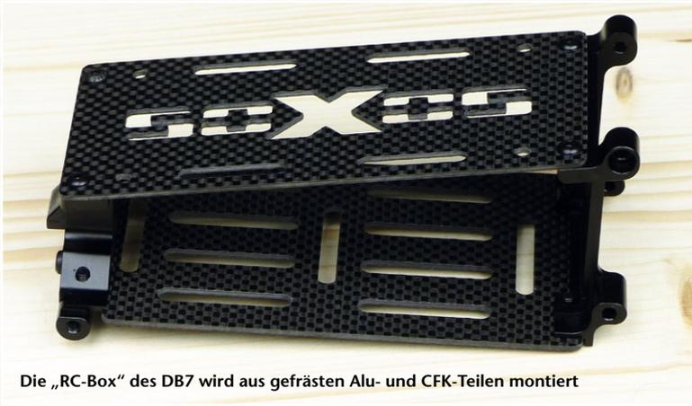
Die „RC-Box“ des DB7 wird aus gefrästen Alu- und CFK-Teilen montiert
