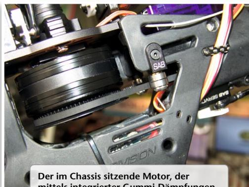
Der im Chassis sitzende Motor, der mittels integrierter Gummi-Dämpfungen direkt mit der Rotorwelle gekoppelt ist. An der Glocke befindet sich auch das Zahnriemenrad für den Heckantrieb
