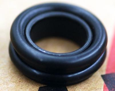
Hier eine der beiden Kunststoff-Buchsen mit eingesetzten O-Ringen. Wir bevorzugen für den weiträumigen und präzisen Flugstil je einen harten (innen) und einen weichen O-Ring (außen). Fertig ist das Dämpfungs-Element
