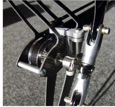
Die Schubstange ist oberhalb des 25er-Heckrohrs geführt. An den Heckrotor-Blatthaltern sind Propeller-Momentgewichte berücksichtigt
