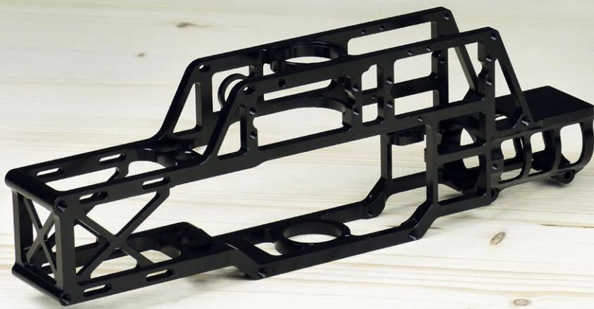
Der markante Rahmen der Soxos-Helis ist wie alle Alu-Teile perfekt gefräst und wurde an einigen Stellen überarbeitet. X-Verstrebungen im vorderen Bereich machen den Rahmen noch verwindungssteifer
