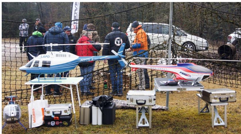
Die Mischung macht's: Scale und F3C nebeneinander. Rechts die F3C-Maschine von Hans Emmenegger, die mit modifizierter JR Forza-Mechanik ausgestattet ist
