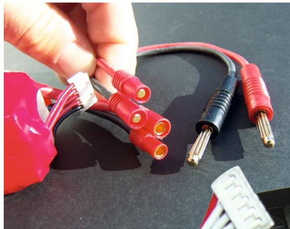
Selbstverständlich sind verpoltsichere und ausreichend dimensionierte Goldkontakt-Stecksysteme Pflicht bei der Nutzung von LiPos
