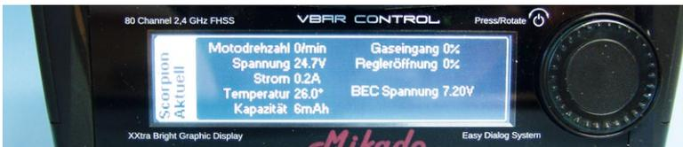
Die aktuell anliegenden Daten können live auf dem Display der VBar Control ausgegeben werden und versorgen die Alarme zum Beispiel nach Erreichen der entnommenen Batterie-Kapazitätsgrenze
