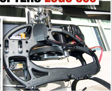
Beim LOGO 600 (auch 550) wurde das Gegenlager mit Abstützung der Rotorwelle übernommen. Verstärkt wurde der Freilauf, und das Riemenrad ist jetzt aus Alu
