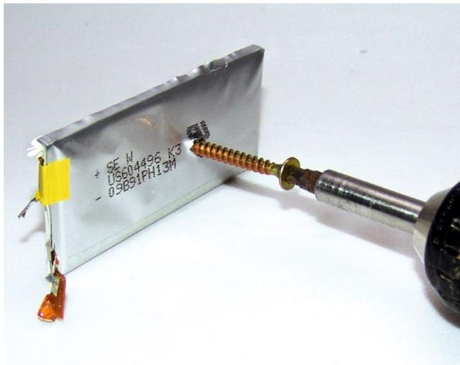
**Tiefentladung** – keine Energie, deswegen auch unkritisch bei mechanischem Schaden. Wird eine Zelle über längere Zeit mit weniger als 2,7 V gelagert oder fällt über kürzere Zeit unter eine Spannung von 1,5 V, kann das aber für interne Kurzschlüsse sorgen. Die Zelle ist in diesem tiefentladenen Zustand nicht kritisch, jedoch eine tickende Zeitbombe. Wenn eine solche Zelle wieder geladen wird, kann sie instabil werden und gegebenenfalls ihren Dienst quittieren
