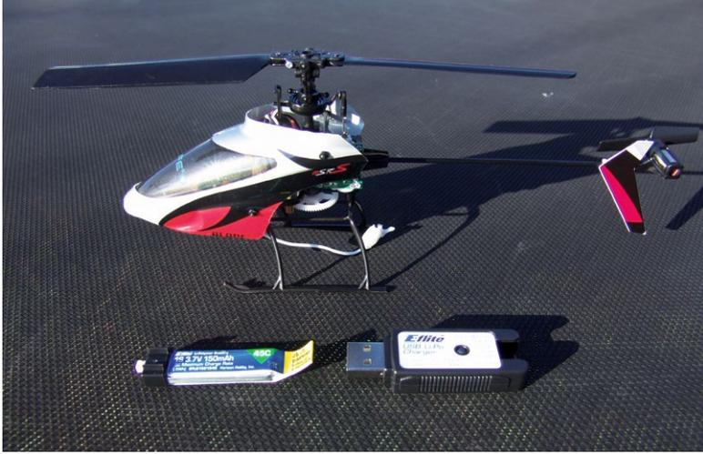
Etwa fünf Minuten Flugzeit sind mit dem serienmäßigen 1s-LiPo möglich, der über den beiliegenden USB-Lader befüllt wird
