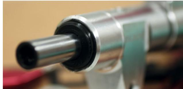
Gut gefettet werden die beiden Dämpfungs-Elemente nach Aufschieben auf die Blattlagerwelle seitlich ins Zentralstück gepresst
