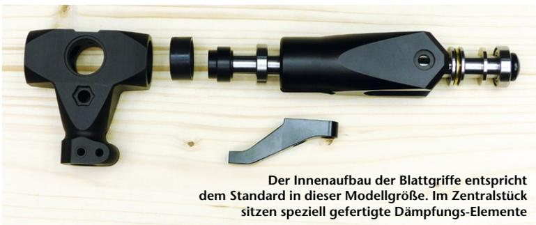
Der Innenaufbau der Blattgriffe entspricht dem Standard in dieser Modellgröße. Im Zentralstück sitzen speziell gefertigte Dämpfungs-Elemente
