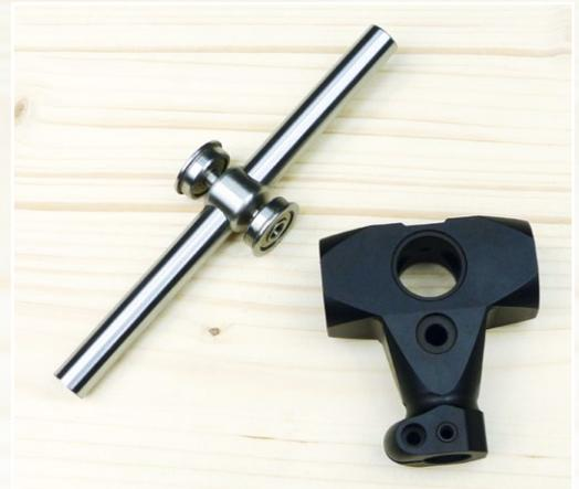
Das neue Rotorkopf-Zentralstück mit Mittenlagerung der Blattlagerwelle
