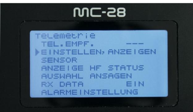
Hochinteressant ist die Möglichkeit, Empfänger über den Sender zu programmieren. Da der beiliegende GR-18 ein vollwertiges Flybarless-System beinhaltet, können alle Parameter dafür über die Fernsteuerung vorgenommen werden
