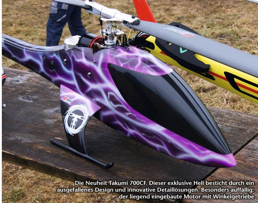
Die Neuheit Takumi 700CF. Dieser exklusive Heli besticht durch ein ausgefallenes Design und innovative Detaillösungen. Besonders auffällig: der liegend eingebaute Motor mit Winkelgetriebe
