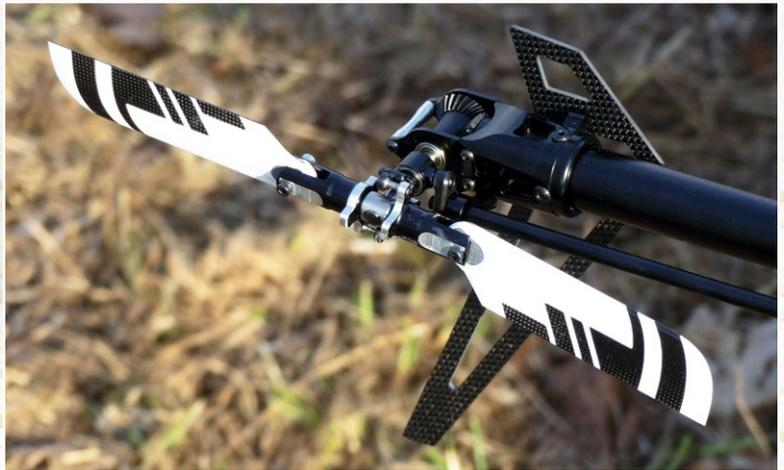
Der Heckrotor des DB7 mit dem „Heli-Pro-Markenzeichen“ – die Torsionsanlenkung
