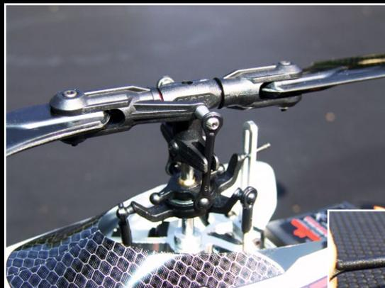
Die Blatthalter werden von hinten angelenkt. Die von der Taumelscheibe zu den Blatthaltern führenden Doppel-Kugelgelenke sind nicht verstellbar – Spurlauf-Einstellen entfällt
