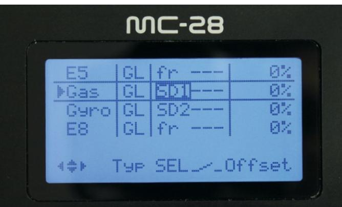
Im Gebermenü können mit wenigen Handgriffen Funktionen Dreh- oder Schieberegler zugeordnet werden
