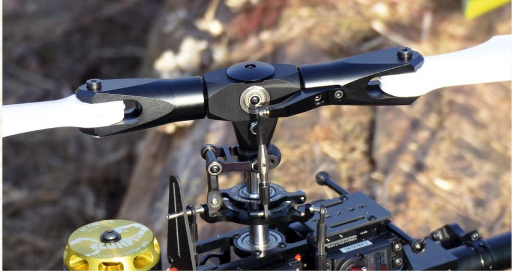
Der Rotorkopf des DB7. Der Mitnehmer ist einseitig ausgeführt und laut Hersteller gewuchtet. Die Taumelscheibe wurde vom alten Soxos übernommen. Der vordere Bolzen ist nun aber mit einem Stift ausgeführt, der in der Führung läuft
