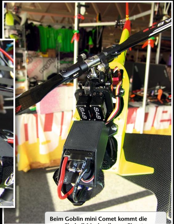
Beim Goblin mini Comet kommt die neue Fireball-Mechanik zum Einsatz, allerdings mit einem heißeren, für 6s-Betrieb ausgelegten Motor
