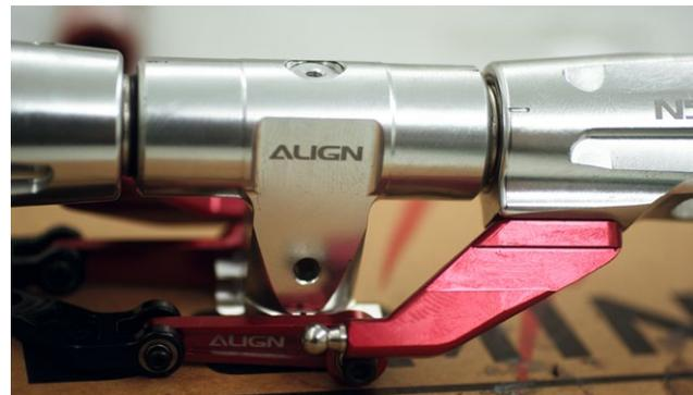
Auf der Blattlagerwelle findet je Seite neben der serienmäßigen 0,5 Millimeter (mm) starken Distanzscheibe (original Align) eine der der Dämpfung beiliegenden, 0,2-mm-Exemplare seinen Platz. Damit wird die Dämpfung entsprechend vorgespannt und die Blatthalter haben in Zugrichtung keinerlei Spiel
