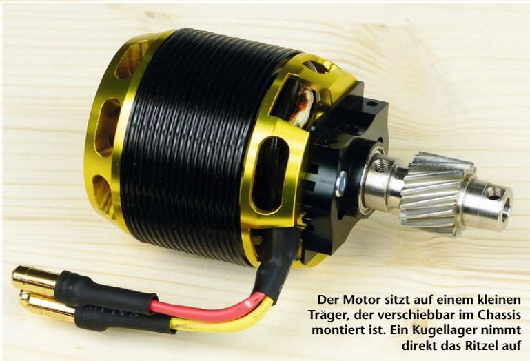
Der Motor sitzt auf einem kleinen Träger, der verschiebbar im Chassis montiert ist. Ein Kugellager nimmt direkt das Ritzel auf
