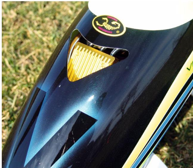
Das Gehäuse des Tribunus 06-120A ist perfekt an die Platzverhältnisse im LOGO angepasst, wo er millimetergenau und ohne zu Scheuern unter der Haube sitzt. Durch die serienmäßige Öffnung fließt der Luftstrom direkt über die Kühlrippen
