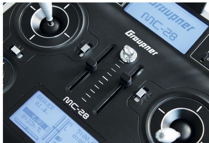
komplett aus Alu gefertigt, da die äußeren Rahmen der Mechaniken aus Kunststoff bestehen. Die Steuerungen überzeugen durch mehrfache Kugellagerungen und Signalerzeugung über zeitgemäße 12-Bit-Hallsensoren. Federdruck, Ratschenfunktion und ähnliches lassen sich mit ein paar Schrauben an die persönlichen Bedürfnisse anpassen.
