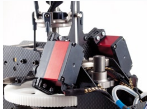
Die beiden vorne angeordneten Rollservos der direkten, symmetrischen Dreipunktanlenkung
