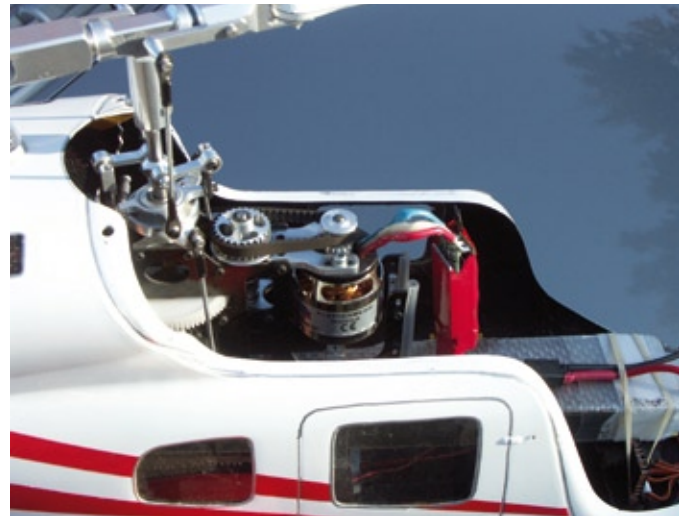
Mit demontierter Rumpfhaut wird deutlich, wie gut die Mechanik erreichbar ist
