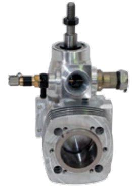
Nach dem Entfernen des Zylinderkopfs wird die Verschraubung des Zylinderfußes sichtbar
