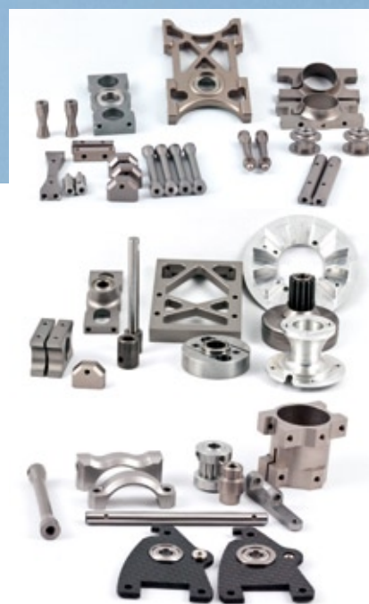
Hier einige der sauber gefertigten, passgenauen, in Grau eloxierten Aluminiumteile des Fury 55
