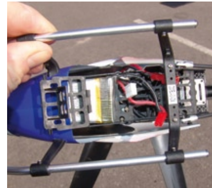
Der Akku wird in einem gesonderten Fach untergebracht, das mit einem Türchen verschlossen wird
