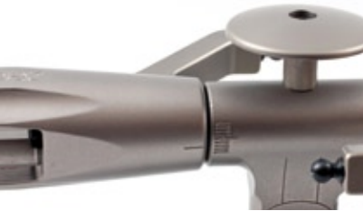
Das erleichtert die Einstellarbeiten ungemein – eine Skala mit Pitchgrad-Markierungen an Zentralstück und Blatthalter
