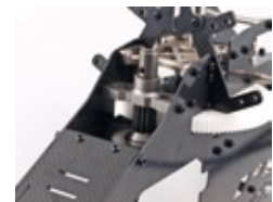
Das sauber geführte Motorritzel und die Sechskant-Starteraufnahme
