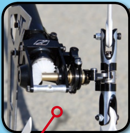
Ganzmetall-Bauweise, spielfreie Doppelanlenkung der Pitch-Schiebehülse sowie ein Starrantrieb – die wesentlichen Merkmale des hochbelastbaren Fusion-Heckrotors
