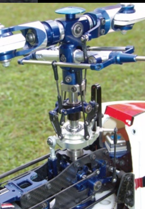
Die SWM-Anlenkung mit der asymmetrischen Winkeinteilung von 135/90 Grad
