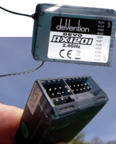
Der serienmäßig zum Fernsteuer-Set gehörende 12-Kanal-Empfänger mit seinen beiden Kurzantennen. Die Servo-Steckkontakte sind stirnseitig angeordnet und entsprechenden JR/Futaba-Schema
