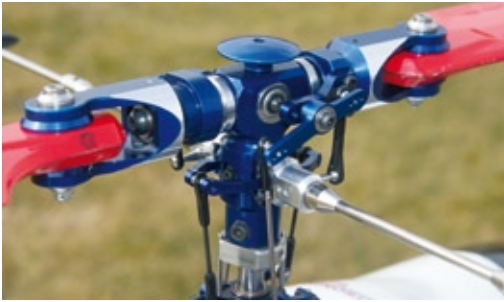
Bestens bewährt und unverändert von der Vorgängerversion des Eagle 3 SWM übernommen – das fürs F3C-Fliegen abgestimmte Hauptrotorsystem SSZ-5 in edler Ganzmetallbauweise
