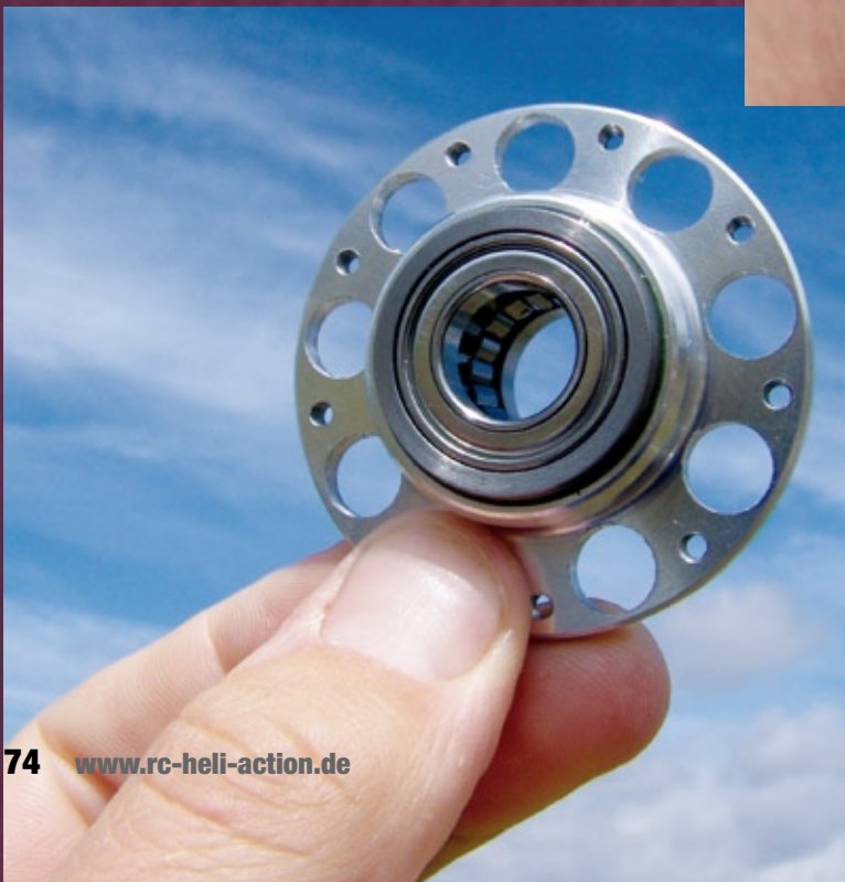
Beispiel einer kompletten Freilaufnabe, die mit Haupt- und Heckabtriebszahnrad montiert ist
