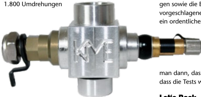
Der serienmäßige Zweinadelvergaser des KME Diamond. Rechts die Hauptkraftstoffzufuhr, links der verstellbare Hebel des Drosselkükens
