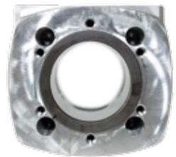
Die im Zylinder eingepresste Laufbuchse wird mit Hilfe einer Verdrehsicherung (Schwernspannstift am Außenrand) sicher in Position gehalten
