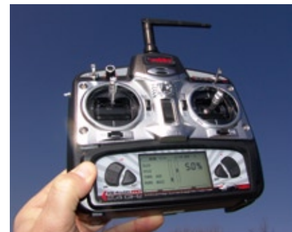
Der robbe-Sender wird mit Gas links ausgeliefert, lässt sich aber auch problemlos auf andere Modi umbauen
