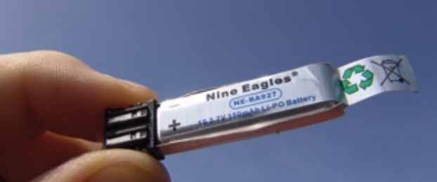
Energieriegel: Der einzellige LiPo-Antriebsakku mit 150 Milliamperestunden Kapazität reicht für etwa sechs bis sieben Minuten Flugzeit
