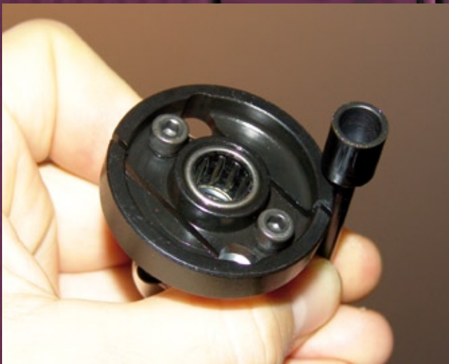
In der Kupplung eines T-Rex 600 verbaut – ein Klemmrollenfreilauf. Hier greift die gehärtete Starterwelle ein
