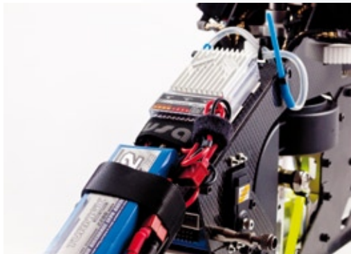
Eine saubere Verlegung aller Kabel ist Pflicht. In den blauen Röhrchen sind die Empfangsantennen untergebracht
