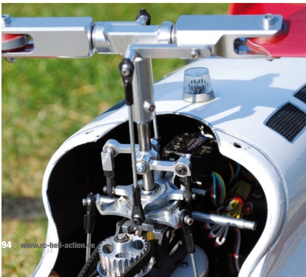
Die ursprünglichen Steuerwege des Acrobat SE mussten für den Umbau auf Zweiblatt-Rigid nicht geändert werden
