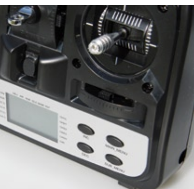
Die einfache Programmierung erfolgt über die vier Taster und mit Hilfe des Displays
