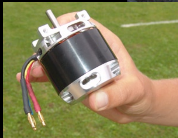
Der Außenläufer K&S PT-90440 Type-3, der im Meistermodell von Uwe Kiesewetter zum Einsatz kommt
