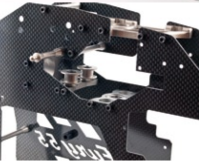
Der verwindungssteife Aufbau des Chassis erfolgt mit Hilfe von Alu-Lagerböcken und -Distanzstücken
