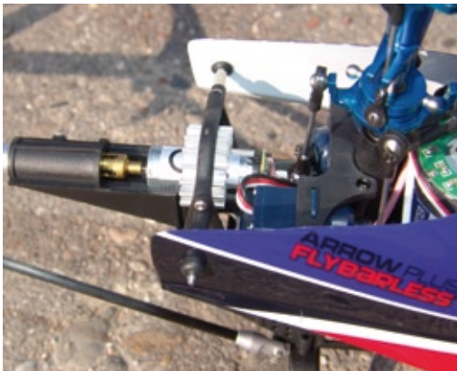
Der gesonderten Heck-Bürstenmotor, der am Heckrohrflansch befestigt ist. Der Heckantrieb erfolgt über eine Welle
