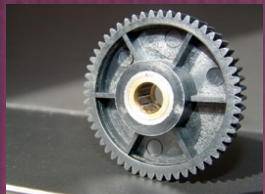
Der in der ersten Getriebstufe einer Graupner/Heim UNI-Mechanik verbaute Klemmrollenfreilauf. Eine entsprechende Führung der Welle gewährleisten vor und hinter dem Freilauf eingesetzte Bronzenbuchsen
