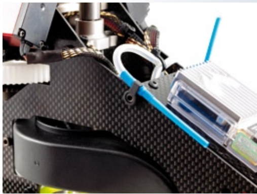
Eine saubere Verlegung aller Kabel ist Pflicht. In den blauen Röhrchen sind die Empfangsantennen untergebracht
