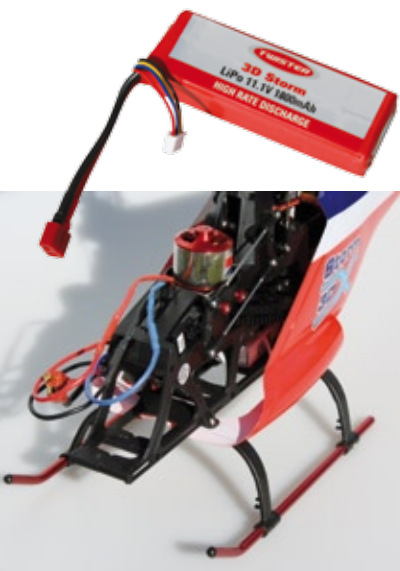
Der 3S-LiPo-Akku wird auf der unteren Platte innerhalb des Chassis verstaut. Hier muss er gut gesichert werden, da der Schacht sehr groß bemessen ist und viel Platz bietet
