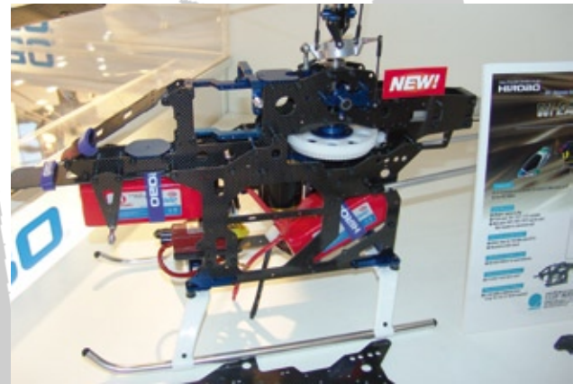
So sieht Hirobo serienmäßig die Unterbringung der beiden geteilten und in Serie verschalteten LiPo-Akkus vor, wie auf der Messe in Nürnberg demonstriert wurde. Die entsprechenden Einbauplatten aus CFK liegen dem Umrüstset bei, ebenso die blau eloxierten Alu-Platten
