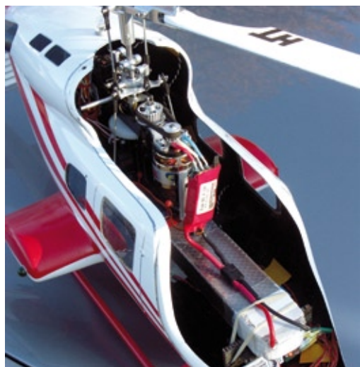
Der im Chassis unter dem Motor verstaute Antriebsakku ist mit zwei CFK-Platten verpackt und mit Schrumpfschlauch überzogen
