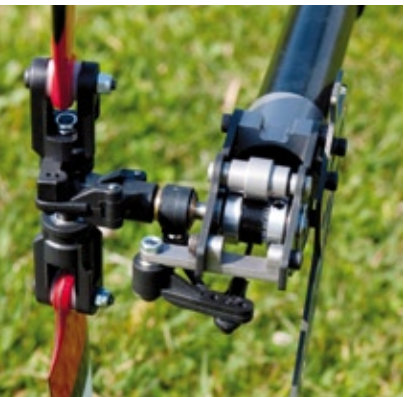
Die fertige Heckrotoreinheit mit den einteiligen Kunststoff-Blatthaltern und der spielarmen Anlenkung
