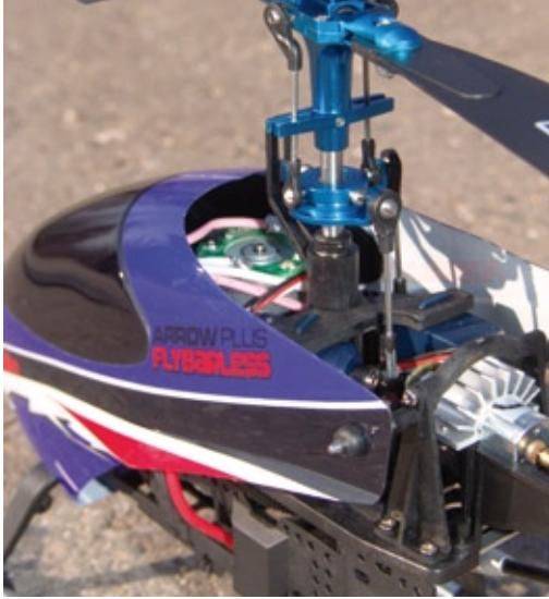
Der blau eloxierte Aluminium-Hauptrotorkopf verfügt über eine sehr weiche Dämpfung
