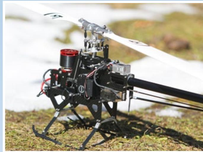
Chassis mit Landegestell und RC-Komponenten. Am Heck das bewährte BSL 251, an der Taumelscheibe die Futaba-Servos S9650
