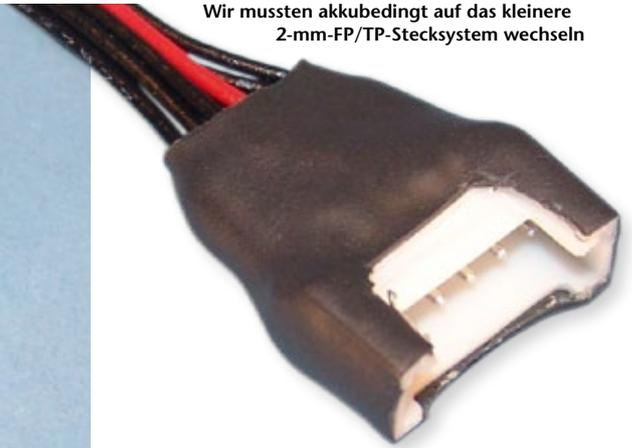
Die Balancer-Anschlusskabel sind gut gemacht. Diese Konstruktion mit den abgewinkelten 2,54-mm-Stiftkontakten und Platine ist extrem haltbar
