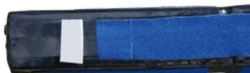
Damit der einmal justierte Schwerpunkt zu jeder Zeit optimal stimmt, sollte der Akku mit einer Arretierung versehen werden, um ihn stets an exakt gleicher Stelle im Modell zu positionieren
