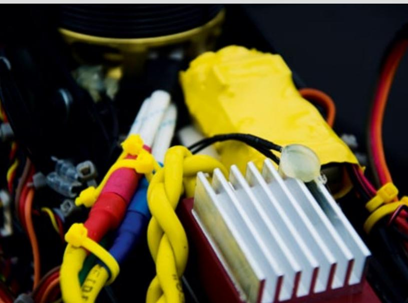
Temperatursensor am Kühlkörper des Controllers, damit auch bei hitzigen Manövern die Temperatur im Auge behalten werden kann
