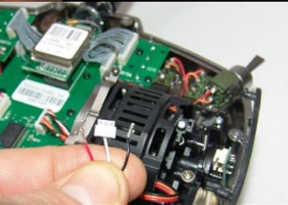
Bei der DX8 muss für Leerlauf vorn das entsprechende Pitchpoti umgepolt werden (siehe Text)
