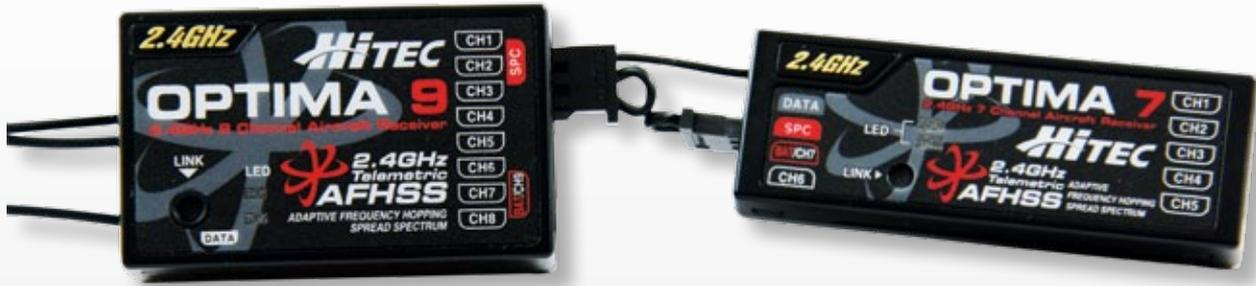
Die beiden telemetriefähigen Empfänger Optima 9 und Optima 7
