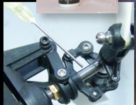
Beim Check sollte auch die Heckrotor-Schiebehülse nicht vergessen werden. Hier bietet sich dünnflüssiges, fein dosierbares Spezialöl an, nachdem die Bauteile sorgfältig gesäubert wurden
