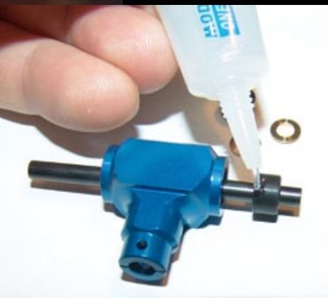
Die im Rotorkopf befindlichen Gummidämpfer und Axiallager sollten regelmäßig gesäubert und gefettet werden
