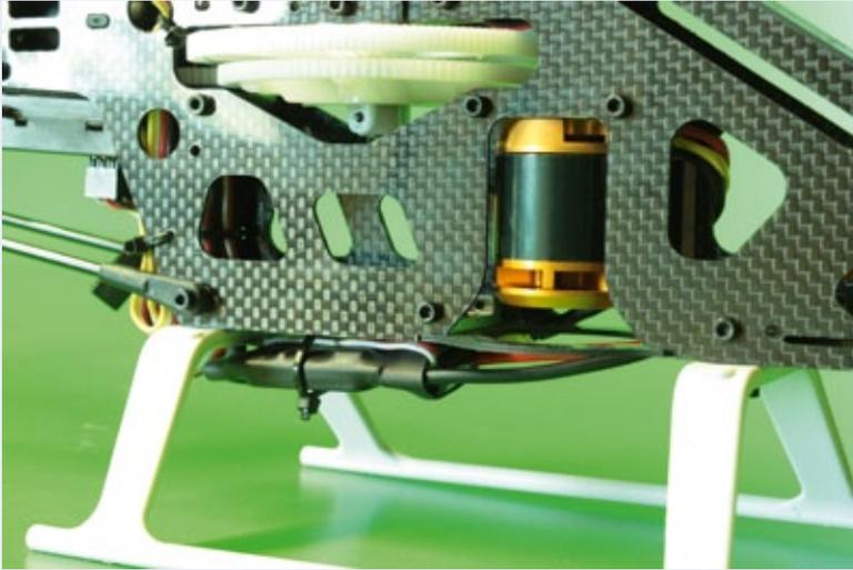
Der borstenlose Außenläufer und das einstufige Getriebe. Der Controller sitzt hinten unter dem Chassis
