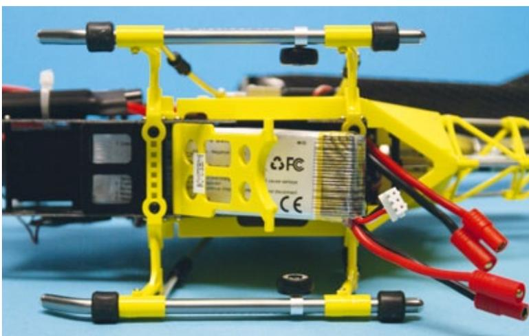
Der LiPo-Akku wird mit durch einen Verschlussdeckel sicher in Position gehalten
