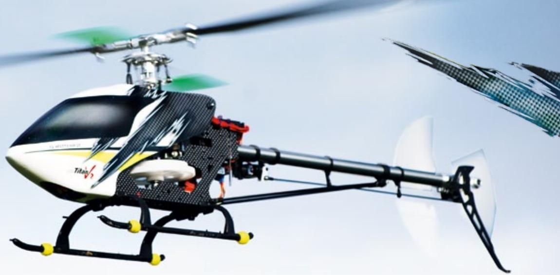
Grad begrenzen. Das macht den Heli bei den ersten Trainingsläufen nicht so nervös auf Pitch und lässt ihn ruhiger schweben. Auch für das Schweben in kleineren Hallen sind diese Werte in Kombination mit einer Hauptrotordrehzahl von 2.200 Umdrehungen pro Minute (U/min) sehr stabil und angenehm.
