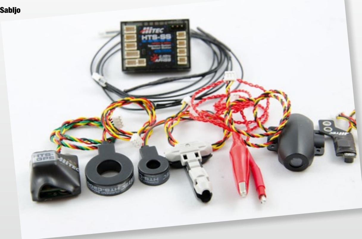
Telemetrie ist in aller Munde. HiTEC, einer der ersten Hersteller, der diese Technologie im Sender integrierte, stellt neue Telemetrie-Produkte für die Aurora 9 vor. In diesem Bericht betrachten wir schwerpunktmäßig die Nitro- (NitroSS) sowie die neue Blue-Sensorstation (BlueSS) – was sie können, welche Sensoren es gibt und wie sie dem Piloten auch im fliegerischen Alltag nützlich sein können.
