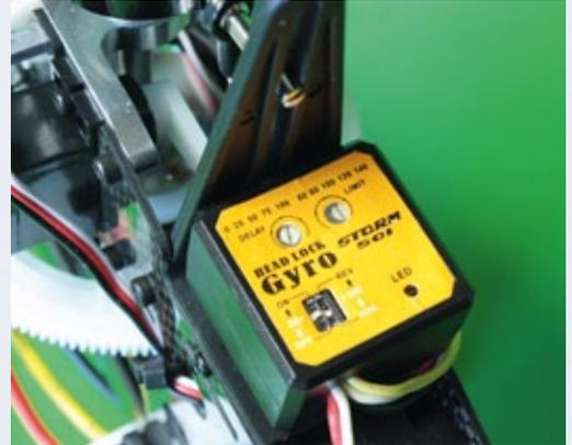
Das Storm 501-Gyro-System sitzt auf der Plattform hinter der Taumelscheiben-Führung
