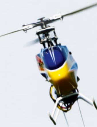
Aluminium ist hier das vorherrschende Element. Einzig die Anlenkungen zwischen den einzelnen Ebenen sind aus Kunststoffgestängen gefertigt. Die Paddel selbst bestehen aus Kunststoff und werden mit einer Madenschraube an der Paddelstange fixiert. Die Blattlagerwelle ist relativ hart gelagert. Der Heckrotor wird mittels eines Zahnriemens angetrieben. Das Gehäuse des Hecks ist aus Alu, die Heckrotorblätter aus Kunststoff.
