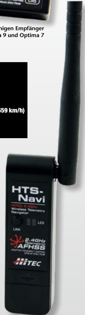
HTS-Navi zur Übertragung der Sensordaten an den PC inklusive Speicherung derselben
