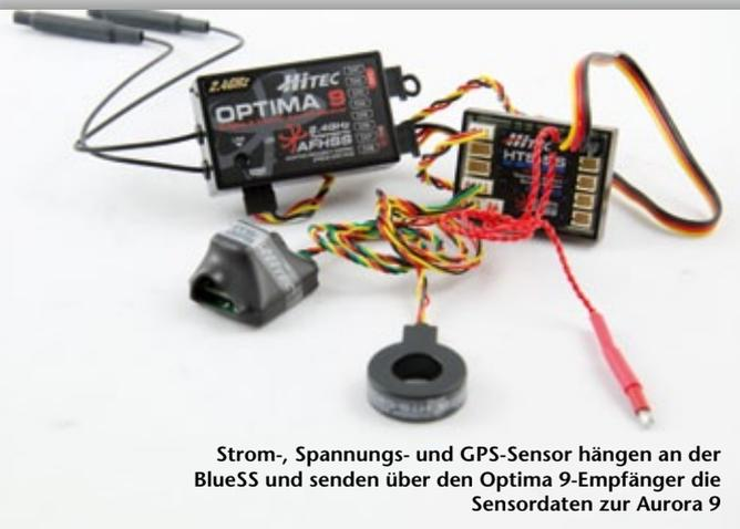
Strom-, Spannungs- und GPS-Sensor hängen an der BlueSS und senden über den Optima 9-Empfänger die Sensordaten zur Aurora 9
