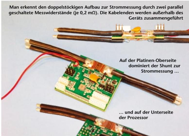
Man erkennt den doppelstöckigen Aufbau zur Strommessung durch zwei parallel geschaltete Messwiderstände (je 0,2 mΩ). Die Kabelenden werden außerhalb des Geräts zusammengeführt
