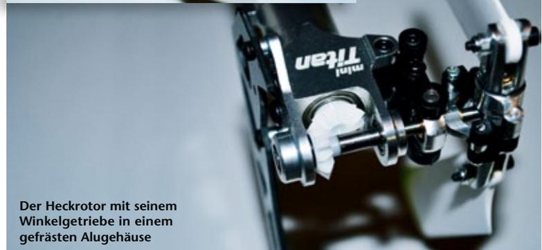
Der Heckrotor mit seinem Winkelgetriebe in einem gefrästen Alugehäuse
