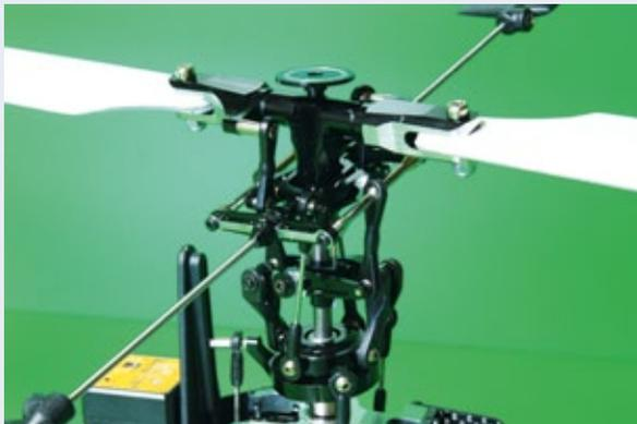
Der stabilisierte Zweiblatt-Hauptrotor ist aus Aluminium gefertigt. Die Kullisse der Stabilisierungsstange ist extrem verwindungssteif ausgeführt. Sämtliche Umlenkhebel sind kugelgelagert ausgeführt
