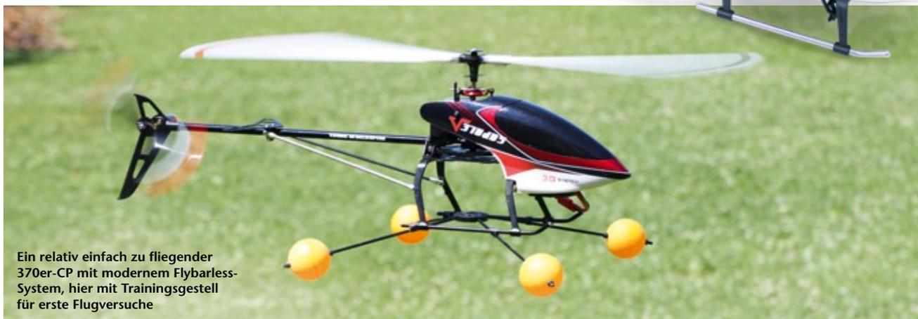
Ein relativ einfach zu fliegender 370er-CP mit modernem Flybarless-System, hier mit Trainingsgestell für erste Flugversuche
