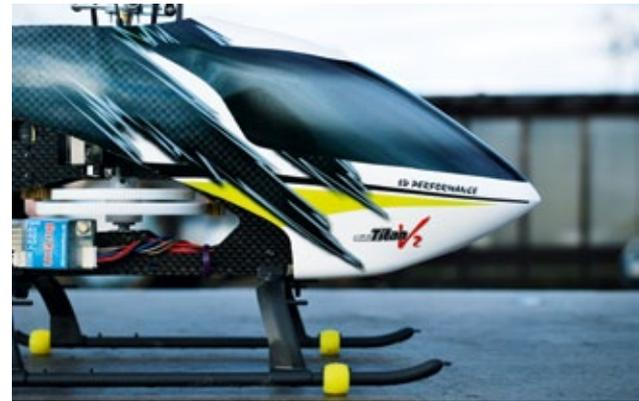
Auf der rechten Chassisseite sitzt unter dem Hauptzahnrad das Messdaten-aufnehmende Unilog. Der Com-Anschluss (ganz links im Bild) wird für die Telemetrieübertragung genutzt
