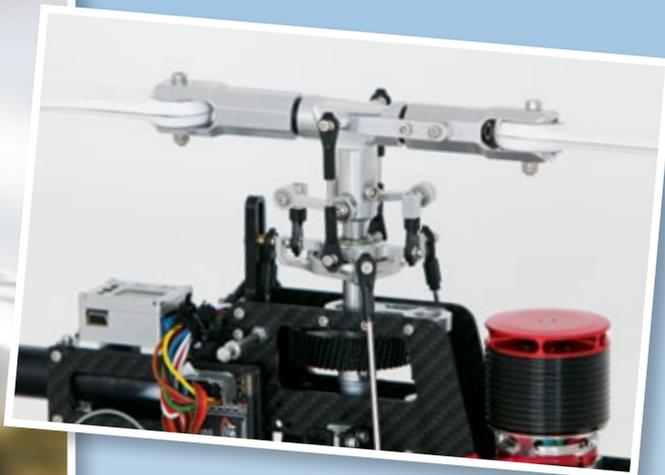
Der Zweiblatt-Flybarless-Rotorkopf in edler Aluminium-Ausführung ist sehr kompakt aufgebaut. Die Mitnehmerhebel sind direkt mit dem Zentralstück verbunden, der gesamte Rotormast baut sehr flach und die Rotorebene sitzt dicht über der Haube
