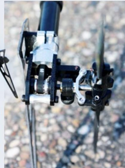
Der riemengetriebene Heckrotor besitzt einteilige Alu-Blatthalter und eine spielarme Anlenkung. Die Klemmung auf dem Alu-Heckrohr übernimmt eine robuste Alu-Aufnahme
