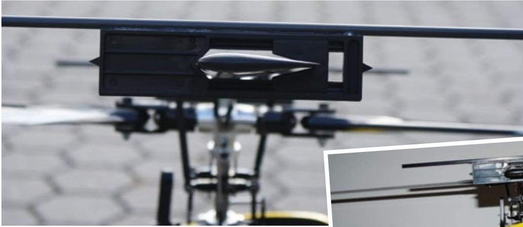
Durch die per Carbonstäbe verlängerten Paddellehren lassen sich die Paddel genauer justieren. Die Carbonstäbe beider Paddel müssen exakt in einer Flucht liegen – und das auch bei 90- beziehungsweise 180-Grad-Drehung des Rotors
