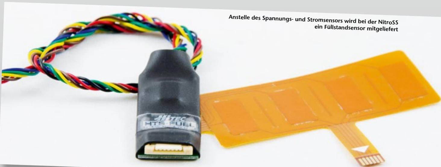
Anstelle des Spannungs- und Stromsensors wird bei der NitroSS ein Füllstandsensor mitgeliefert
