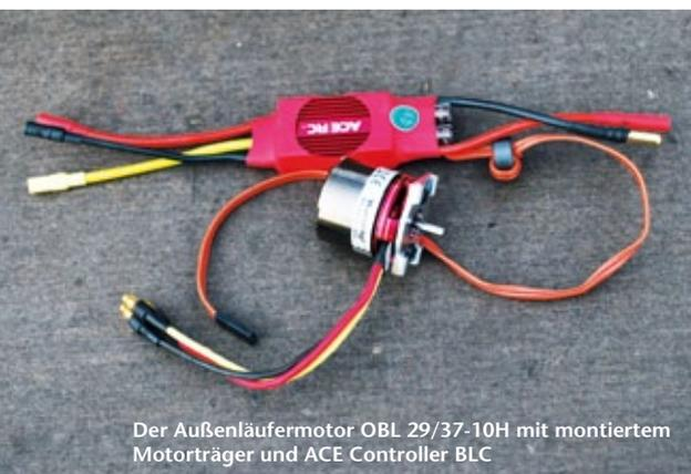
Der Außenläufermotor OBL 29/37-10H mit montiertem Motorträger und ACE Controller BLC
