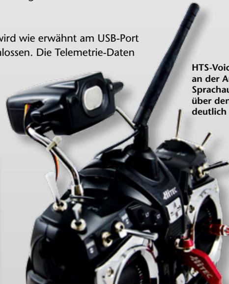
HTS-Voice montiert an der Aurora. Die Sprachausgabe wird über den Lautsprecher deutlich ausgegeben
