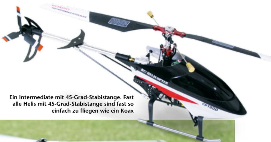
Ein Intermediate mit 45-Grad-Stabstange. Fast alle Helis mit 45-Grad-Stabstange sind fast so einfach zu fliegen wie ein Koax
