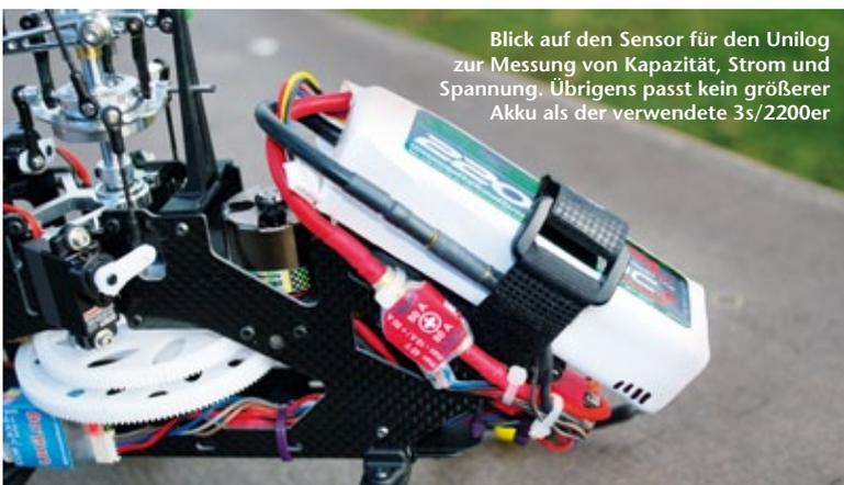
Blick auf den Sensor für den Unilog zur Messung von Kapazität, Strom und Spannung. Übrigens passt kein größerer Akku als der verwendete 3s/2200er
