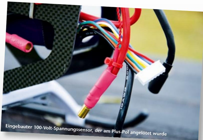
Eingebauter 100-Volt-Spannungssensor, der am Plus-Pol angelötet wurde
