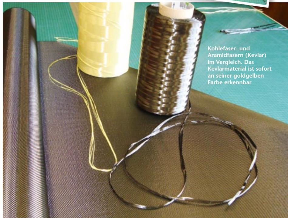
Kohlefaser- und Aramidfasern (Kevlar) im Vergleich. Das Kevlarmaterial ist sofort an seiner goldgelben Farbe erkennbar
