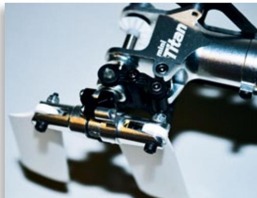
Die sehr aufwendig konstruierte Scheren-Heckrotoranlenkung. Die Heckrotor-Blatthalter sind einteilig und aus Metall gefertigt
