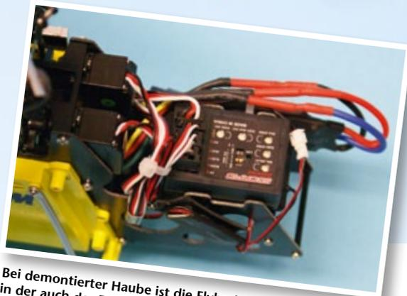
Bei demontierter Haube ist die Flybarless-Elektronik erkennbar, in der auch der Empfänger integriert ist. Die Wirkung der einzelnen Funktionen kann über Potis eingestellt werden, funktioniert jedoch out of the box hervorragend. Unmittelbar dahinter die beiden Rollservos der 120-Grad-Anlenkung
