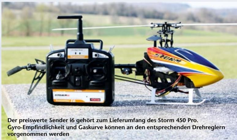
Der preiswerte Sender i6 gehört zum Lieferumfang des Storm 450 Pro. Gyro-Empfindlichkeit und Gaskurve können an den entsprechenden Drehreglern vorgenommen werden
