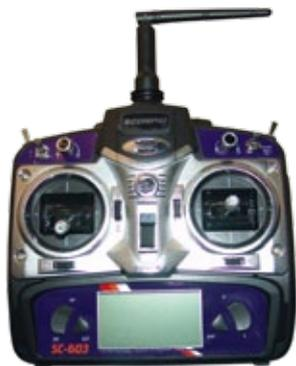
Der vorprogrammierte Sechskanal-Sender mit Display gehört zum Ready-to-Fly-Set der Lama
