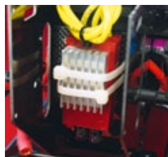
Der Controller Jive 120 HV wurde vor der Montage der Empfängerakku-Platte im Chassis verstaut
