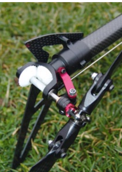
Der Heckrotor mit seinem offenen Winkelgetriebe läuft sehr leichtgängig und präzise. Hier sind alle Teile, bis auf die Kegelräder, aus Metall gefertigt
