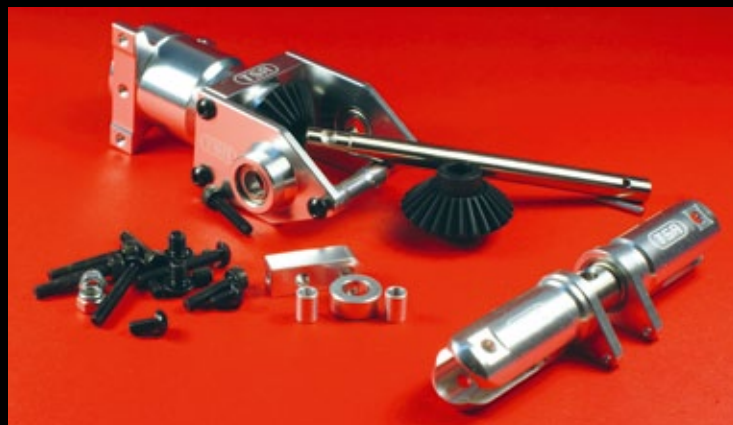
Auch der Heckrotor brilliert durch spielarme Anlenkung und robusten Aufbau
