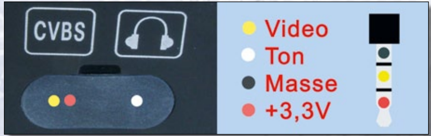
Kontaktbelegung der Videobuchse mit Videoausgang, Tonleitung und Stromversorgung für den Anschluss einer Videobrille oder eines Monitors
