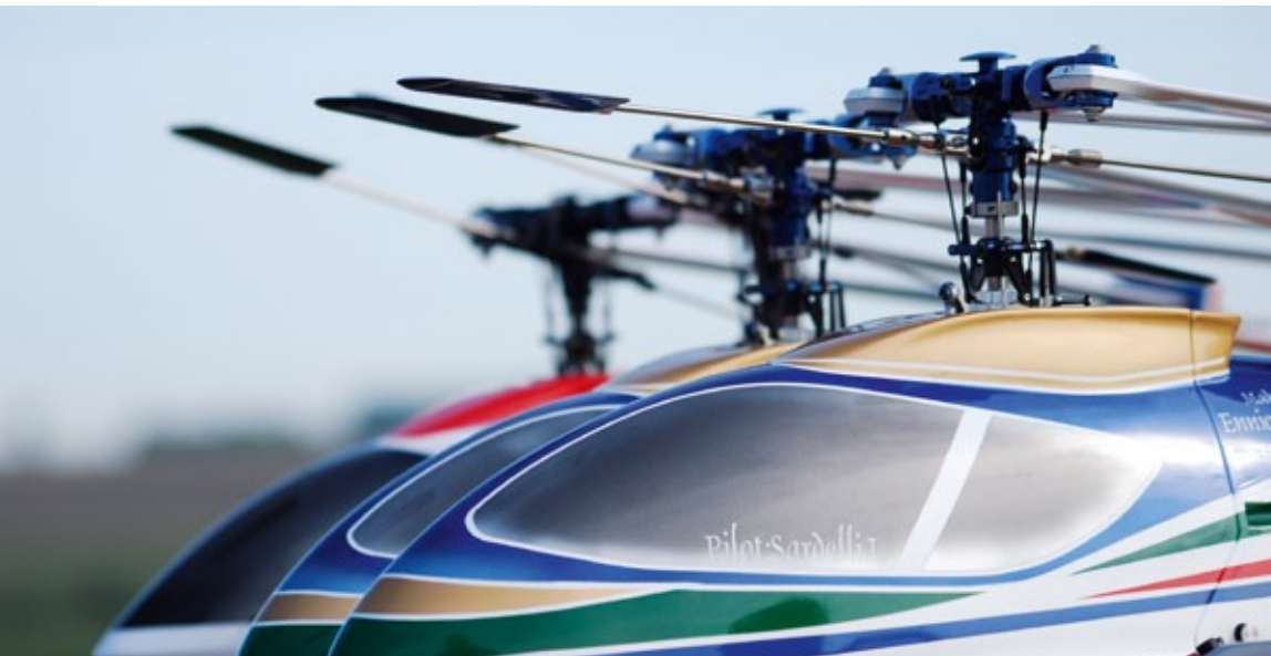
Die Paddereinheit sorgt für ein ausgeglichenes Steuerverhalten des Helis. Das passiert sowohl aerodynamisch (Blattverstellung) als auch mechanisch (Kreisel, rotierende Masse)
