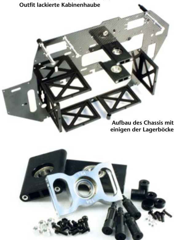
Die drei Rotorwellenlager und diverse Kleinteile. Das obere Domlager ist aus Alu gefertigt
