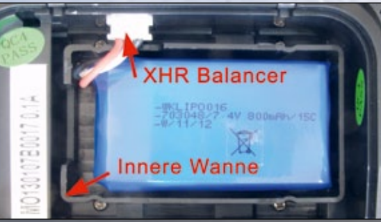
Blick ins Batteriefach. Das Entfernen der Wanne schafft Platz für noch größere LiPos
