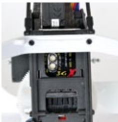
Trotz der engen Platzverhältnisse sind die Potis des 3GX noch gut von unten erreichbar
