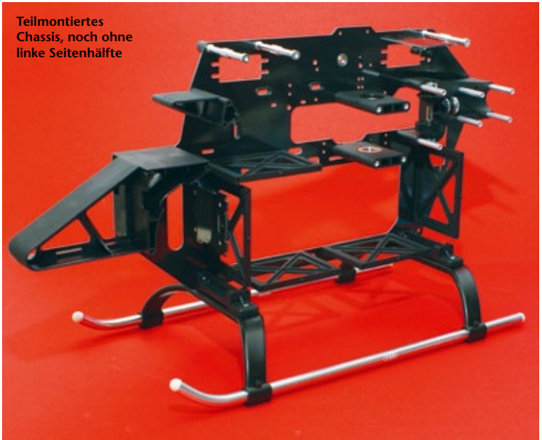
Klasse gemacht – der Motorträger mit integriertem, oberem Stützlager fürs Ritzel
