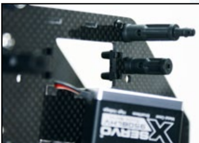
Die Montage der Servos wird durch spezielle Kunststoff-Einsätze enorm vereinfacht
