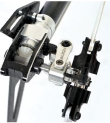
Der Heckrotorantrieb erfolgt über Starrwelle in Verbindung mit einem Kunststoff-Kegelradgetriebe. Die Anlenkung der Blatthalter hat geringfügig Spiel, was sich im Flug allerdings nicht negativ bemerkbar macht
