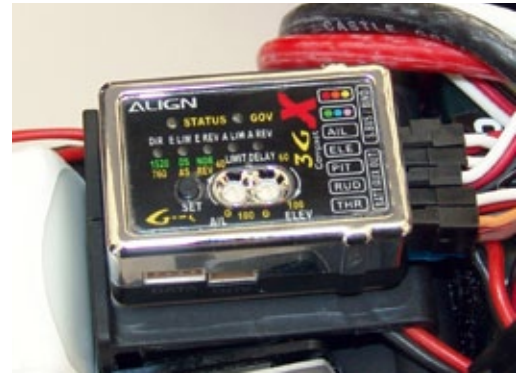
Das Align 3GX ist eines der wenigen FBL-Systeme auf dem Markt, das keinen internen Taumelscheibenmischer hat, sondern diesen senderseitig voraussetzt
