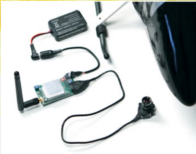
Als FPV-Technik kamen aufgrund ihrer Kompaktheit Komponenten von FatShark zum Einsatz. Das Live-Bild der am Heli befestigten Mini-Kamera wird per 5,8-GHz-Link direkt in eine Dominator-Videobrille übertragen. Der Empfänger ist bereits unter einer der beiden Frontblenden integriert
