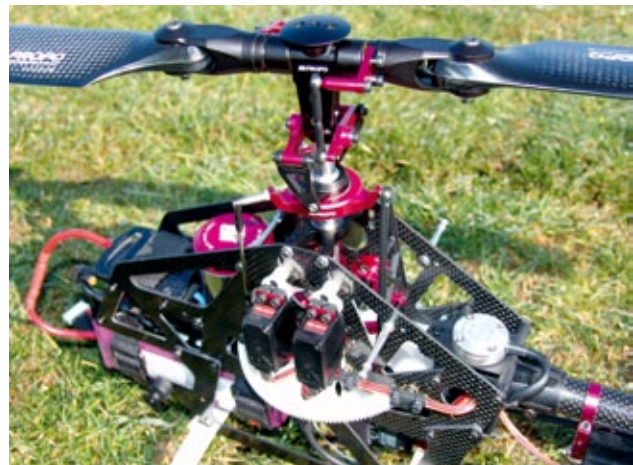
Die Anlenkung des Rotorkopfs erfolgt über kugelgelagerte Umlenkhebel, die den Weg reduzieren und gleichzeitig den Innenring mitnehmen
