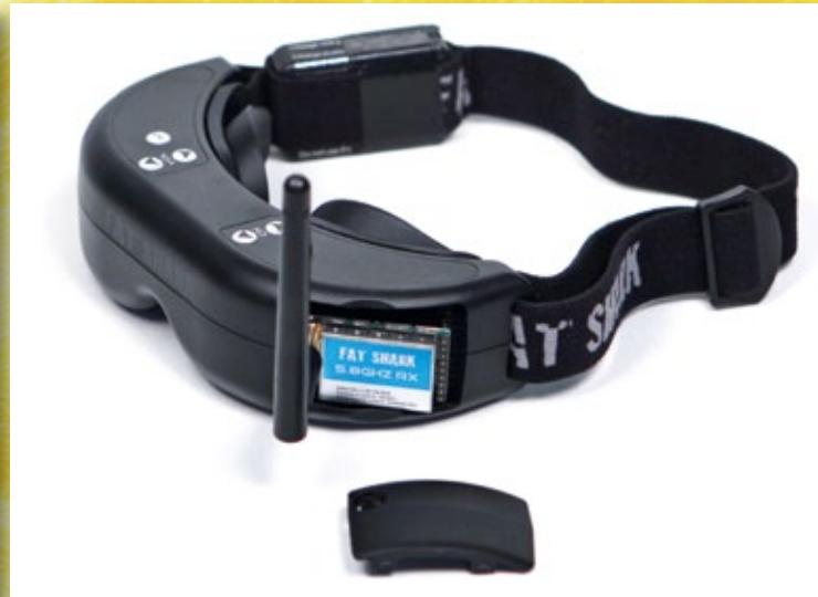
Als FPV-Technik kamen aufgrund ihrer Kompaktheit Komponenten von FatShark zum Einsatz. Das Live-Bild der am Heli befestigten Mini-Kamera wird per 5,8-GHz-Link direkt in eine Dominator-Videobrille übertragen. Der Empfänger ist bereits unter einer der beiden Frontblenden integriert
