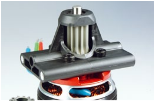
Klasse gemacht – der Motorträger mit integriertem, oberem Stützlager fürs Ritzel
