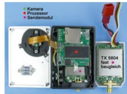
Das Sendemodul der iLook ist bis auf Kleinigkeiten baugleich zu den TX5803/4-Modulen
