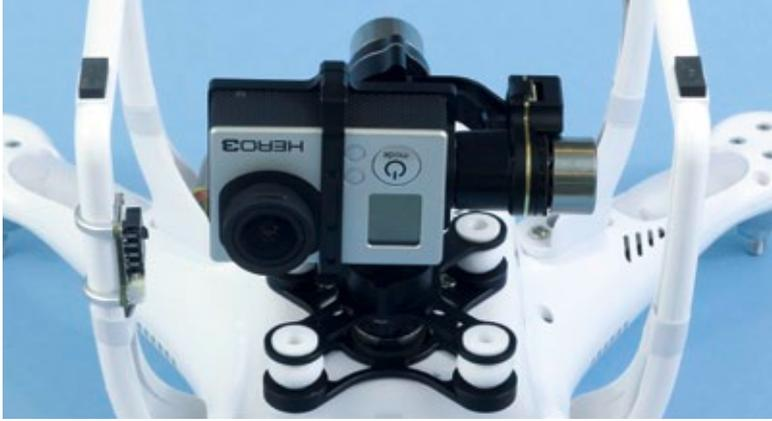
Der Hochachsenmotor des Gimbals verschwindet zum Teil in der im Kunststoffgehäuse angebrachten Bohrung. Daraus resultiert Bodenfremheit
