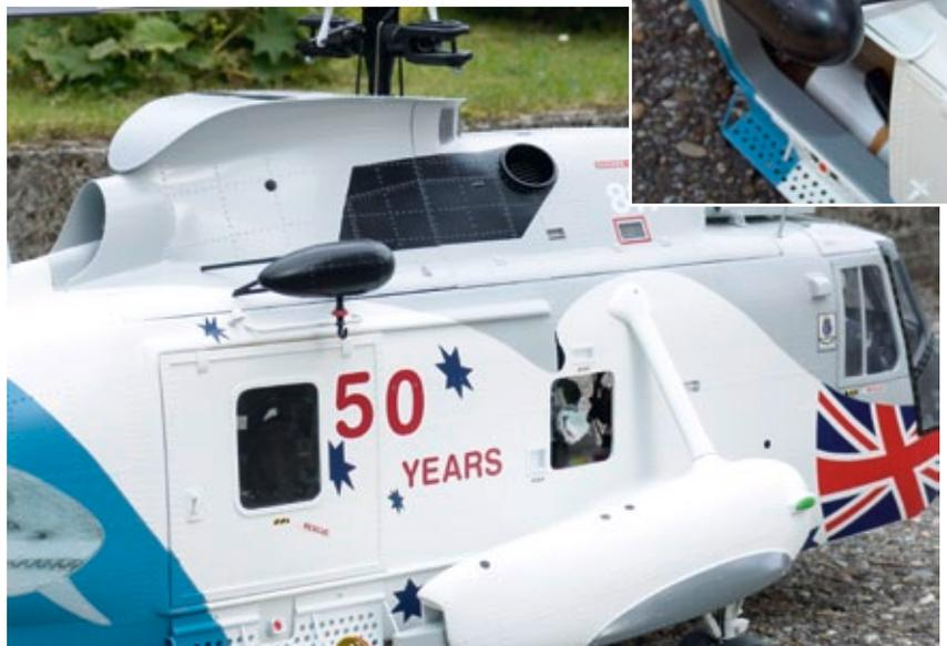
Die Seilwinde befindet sich über der rechten Schiebetür
