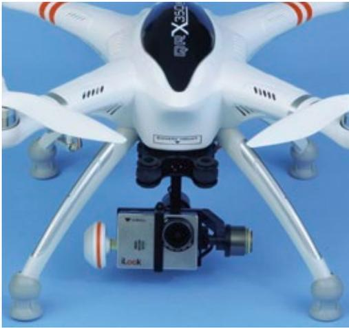
Gummistiefel halten die Kamera knapp über dem Boden
