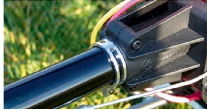
Die Klemmschelle aus Metall sichert das Heckrohr dauerhaft gegen die Vorspannung des Riemens
