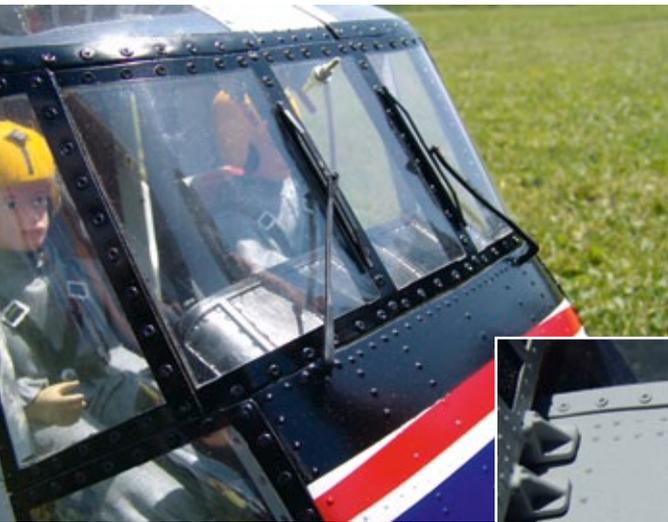
Cockpit- und Frontverglasung wurden mit winzigen Märklin-Senkkopfschrauben befestigt. Die Nieten wurden vor dem Lackieren mittels Spritze und Weißleim aufgebracht
