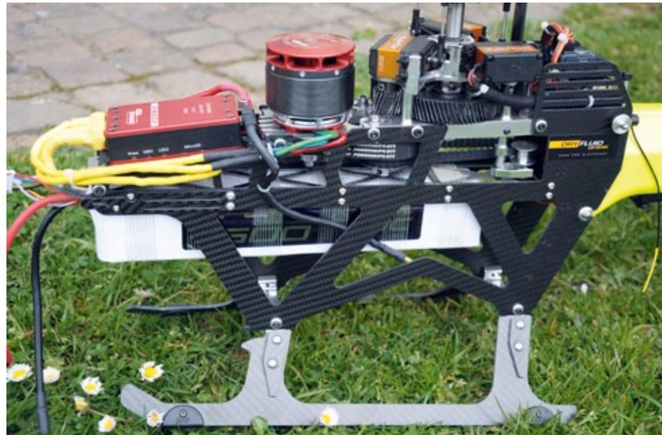
Das leichte Carbon-Tuning-Chassis von SHS. Alle Komponenten sind geschützt und an zentralen Positionen untergebracht
