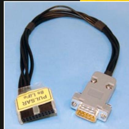
Das ist das selbstgebaute Balancer-Kabel für den Pulsar, das zum Laden der LiFeYPo-Akkus verwendet wird
