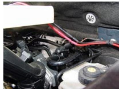
An einem Halteklipp der Karosserie abgefangen, laufen die Kabel mit den am Ende isolierten Buchsen Richtung Ladetisch
