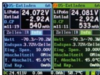
Beim gleichzeitigen Entladen von zwei LiPo-Akkus beträgt die Entladeleistung asynchron 2 x 70 Watt
