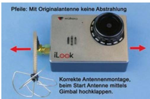
So könnte der Ersatz für die Serienantenne montiert werden. Die iLook ist auch einzeln zur universellen Nutzung erhältlich
