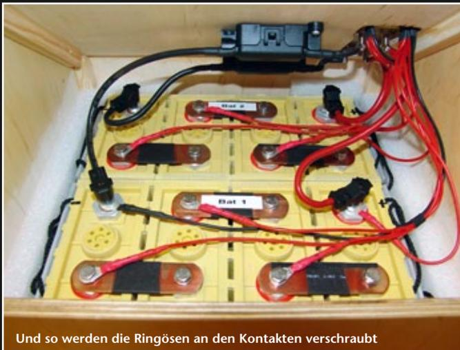
Und so werden die Ringösen an den Kontakten verschraubt
