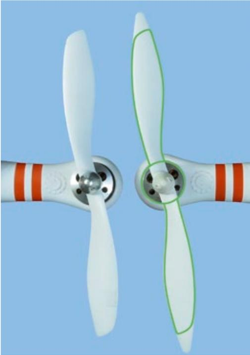
Die neuen (rechts im Bild) und alten Rotoren sind in Form und Steigung bis auf eine kleine Verlängerung an den Spitzen identisch
