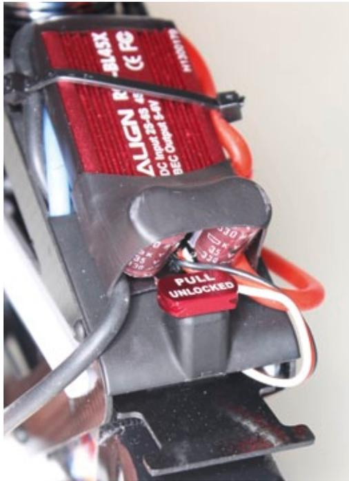
Der 6s-LiPo wird auf der Akkuplatte befestigt, die in die Führungsschienen des Chassis eingeschoben wird. Mittels einer Klemmung wird die Einheit an ihrer Position fixiert. Zieht man den Hebel hoch, löst sich die Arretierung
