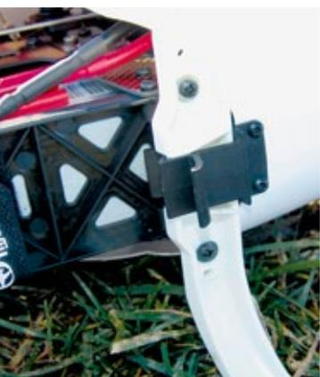
Der Halteclip der Kabinenhaube sorgt für klapperfreien Sitz und lässt sich trotzdem in Sekundenschnelle lösen
