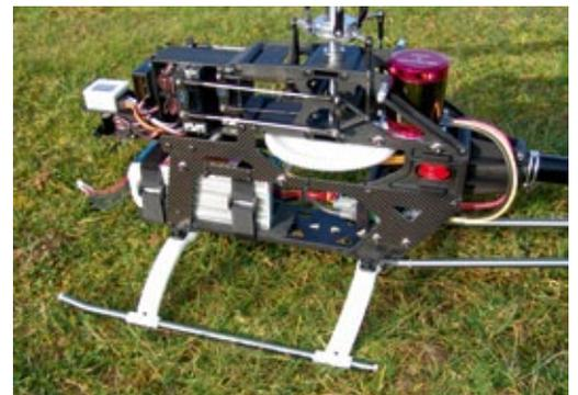
Die Schwerpunktlage lässt sich exakt einhalten, wenn der Flugakku bündig an der Vorderkante der Bodenplatte liegt. Alle Gestänge verlaufen exakt rechtwinklig
