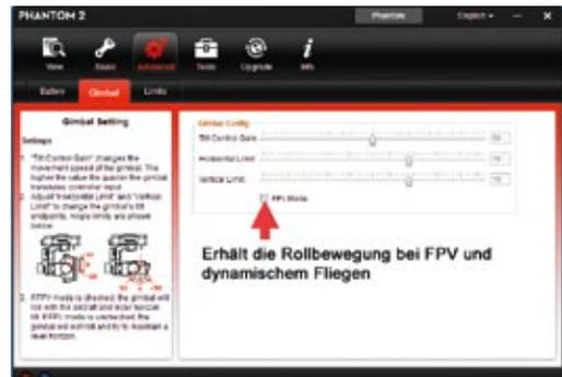
Aktiviert man über die Phantom-Software den FPV-Mode, wird die Roll-Stabilisierung des Gimbals teilweise ausgeschaltet
