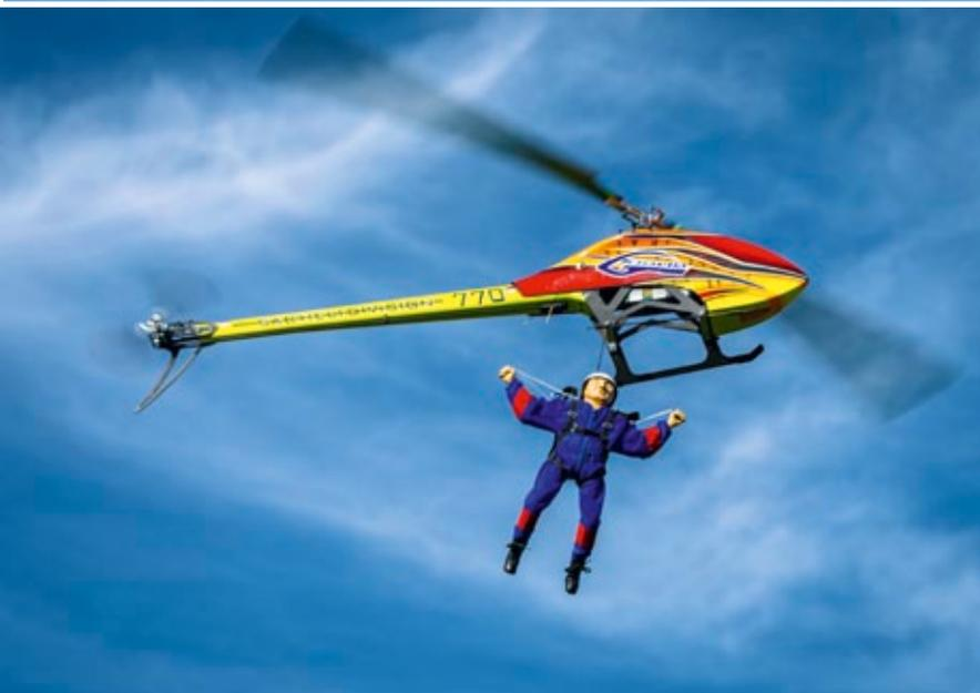
Auch dafür lässt sich ein Goblin 800 verwenden – als Lift für unsere Fallschirmspringer. Bei dem großen Rotordurchmesser sinkt natürlich dementsprechend die Kreisflächenbelastung. Das Flybarless-System 3SX erlaubt via Horizont-Modus ein gefahrloses Steigen bis an die Sichtgrenze. 350 Meter über Startniveau sind absolut kein Problem
