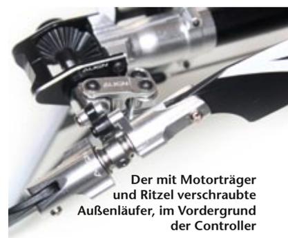
Der mit Motorträger und Ritzel verschraubte Außenläufer, im Vordergrund der Controller
