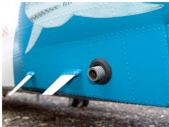
Unmittelbar hinter den kleinen Haiflossen befindet sich der Auslassstutzen des Schalldämpfers
