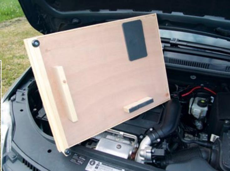
Holzleisten an der Unterseite des Ladetischs gleichen den Höhenunterschied zum Motordeckel aus
