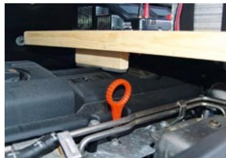
GummifüÙe sorgen für sicheren Halt und verhindern ein Verkratzen der Kunststoffteile am Frontend
