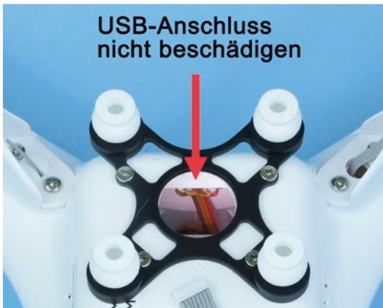
Will man die Bodenfreiheit erhalten, muss in den alten Phantom 2 ein entsprechendes Loch für den Hochachsenmotor gebohrt werden. Die obere Montageplatte dient als Schablone zum Anzeichnen
