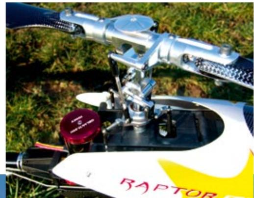
Der Hauptrotorkopf ist komplett aus Alu gefertigt und das Zentralstück gewichtsmindernd ausgefräst
