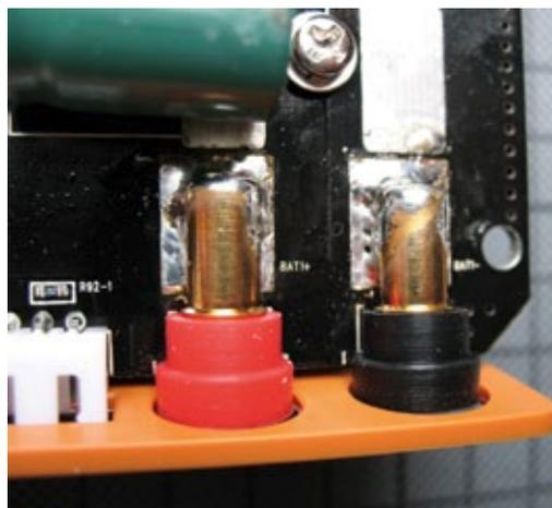
Die in der Vergangenheit geäußerte Kritik an der Verlötlung der Anschlussbuchsen ist hier effizient behoben worden – alle Buchsen wurden auf ganzer Länge verlötet
