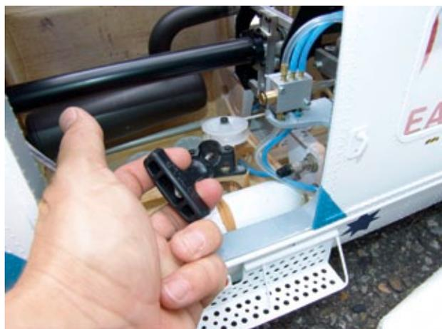
Der Seilzugstart des Zenoah-Benzinmotors erfolgt über die rechte Schiebetür, wobei eine Umlenkrolle zum Einsatz kommt
