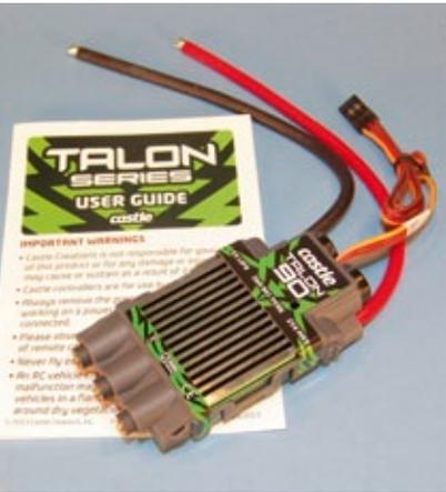
Der beiliegende Controller Talon 90 von Castle Creations ist speziell für Helis mit 6s-Antrieb ausgelegt. Neben 90 Ampere maximalem Strom verfügt er über ein leistungsstarkes BEC
