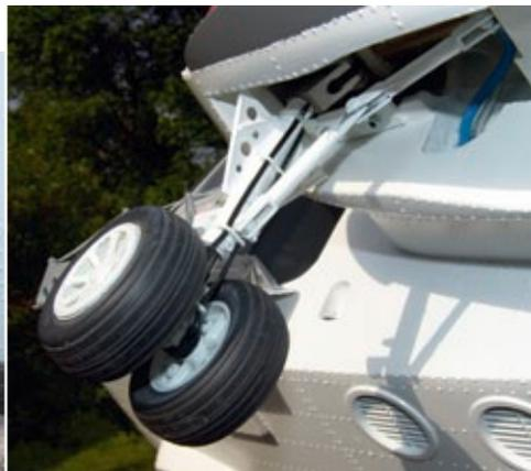
Detail des pneumatischen Einziehfahrwerks mit vorbildgetreuer Fahrwerksbein-Ausführung
