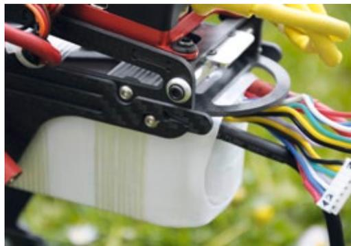
Die präzise gefertigte Akkuschiene und deren Clip-Halterung. In der Praxis funktioniert das Ganze sehr einfach und hält den Akku sicher an Ort und Stelle
