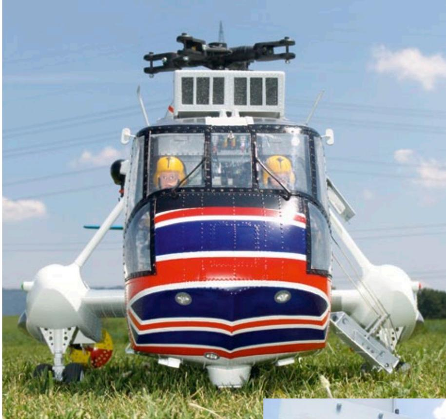
Markante Front-Silhouette der Sikorsky SH-3D Seaking mit ihren relativ klobigen Nasenpartie sowie den beiden abgestrebten Stummelflügeln
