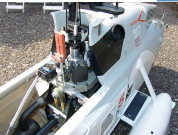
Blick auf den hinteren Teil der Mechanik mit heruntergesetztem Zahnriemen-Heckabtrieb
