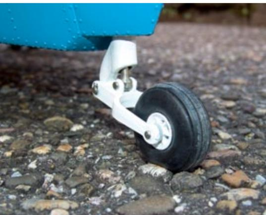
Das gefederte und drehbar gelagerte Spornrad mit Luftkammerreifen
