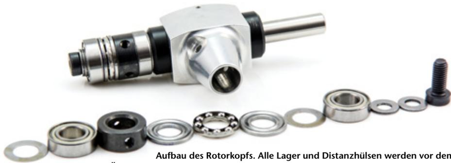
Aufbau des Rotorkopfs. Alle Lager und Distanzhülsen werden vor dem Überstülpen der Blatthalter auf der 8 Millimeter starken Blattlagerwelle montiert
