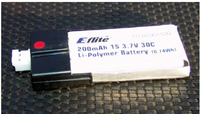
Der kleine 1s-LiPo-Akku mit einer Kapazität von 200 Milliamperestunden reicht für eine Flugzeit von knapp fünf Minuten
