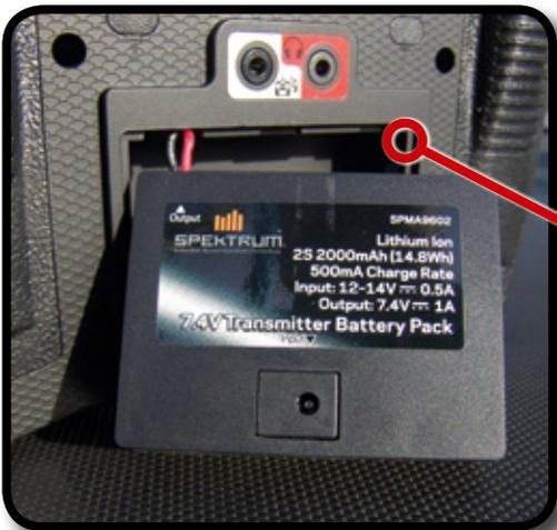
Für lange Betriebszeiten der DX7 sorgt der serienmäßig verbaute 2s-Lithium-Ionen-Akku mit einer Kapazität von 2.000 Milliampere-stunden. Ein passendes Ladegerät (Netzteil) liegt dem Set ebenfalls bei
