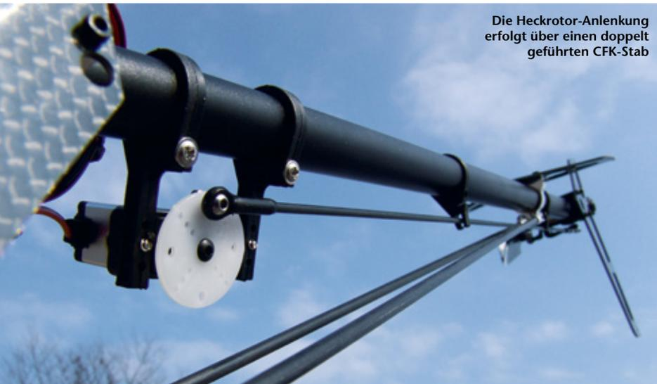
Die Heckrotor-Anlenkung erfolgt über einen doppelt geführten CFK-Stab
