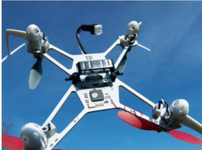
Auf der Oberseite des Kopters befindet sich die Kunststoff-Akkuaufnahme. Bei dem am rechten Ausleger umgewickelten Kupferlackdraht handelt es sich um die Empfangsantenne
