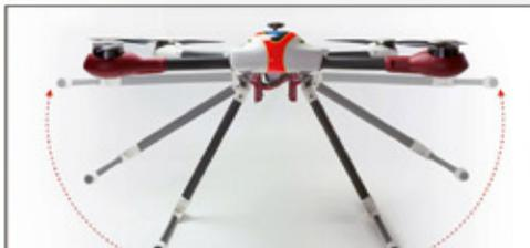
Durch die extrem leise einziehbaren Kufen wird bei Verwendung eines Gimbals eine störungsfreie Sicht durch die Kamera ermöglicht.
