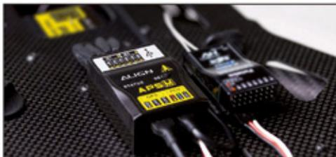
Neue APS-M Multirotor Steuereinheit für Multikopter mit 4, 6 und 8 Rotoren.
