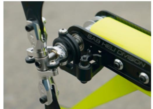
Detail der Befestigung des Heckrotors am Mono-Boom. Zum Einstellen der Zahnriemenspannung gibt es Langlöcher in den Seitenplatten
