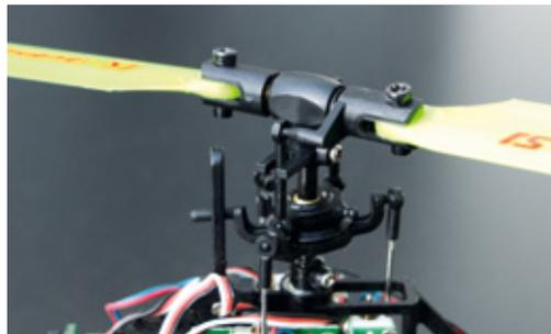
Detail des Hauptrotor-mastes mit der Kunststoff-Taumelscheibe, den Gabelführungen sowie den verstellbaren Taumelscheiben-Anlenkungen. Die Null-Positionen der Servos können über das Telemetrie-Menü der Flybarless-Einheit korrigiert werden
