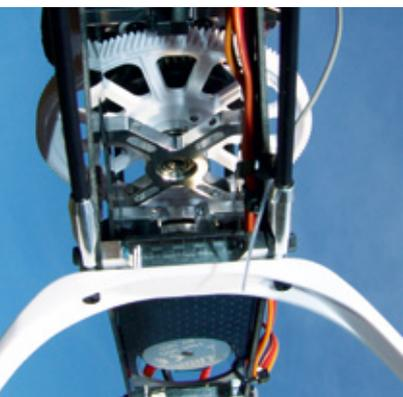
Der dritte Lagerbock – Ansicht von schräg unten – sorgt für optimale Führung der Hauptrotorwelle
