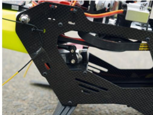
Das im linken Seitenteil verschraubte Heckservo
