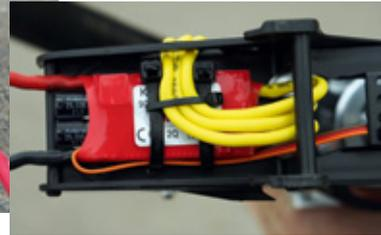
Blick von unten auf den Kontronik-Controller, der inklusive seiner Motoranschlüsse mit Kabelbindern festgezurrt wurde
