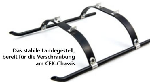
Das stabile Landegestell, bereit für die Verschraubung am CFK-Chassis
