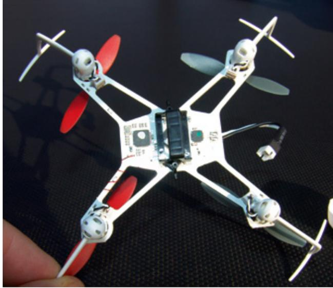
Im Wesentlichen besteht der Kopter aus einer stabilen Platine, auf der die Elektronikeinheit untergebracht ist. Die Motoren stecken in Kunststoff-Aufnahmen
