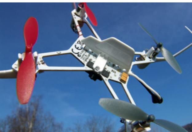
Auf der Unterseite des Blade – die Luftschrauben sind unten angeordnet – befindet sich im Mittelteil eine Kunststoff-Finne zum Schutz der Props
