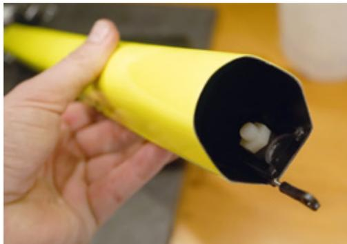
Im Mono-Boom befindet sich die Sollbruchstelle in Form einer Nygonschrauben-Befestigung. Deutlich zu erkennen ist auch das Heckgestänge, das innerhalb des Heckauslegers geführt wird
