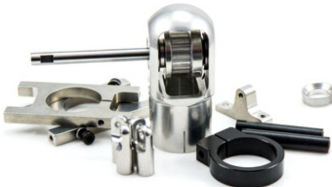
Teile zur Montage des Heckrohrs wie auch des Heckrotorgehäuses
