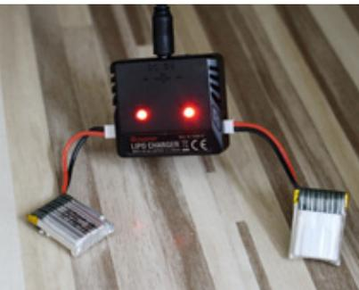
Dank des „Duo-Laders“ muss man nur kurze Flugpausen einlegen. Die beiden LED informieren über den Ladezustand. Nach 25 Minuten sind die im Lieferumfang enthaltenen LiPo-Akkupacks mit einer Kapazität von jeweils 180 Milliamperestunden voll
