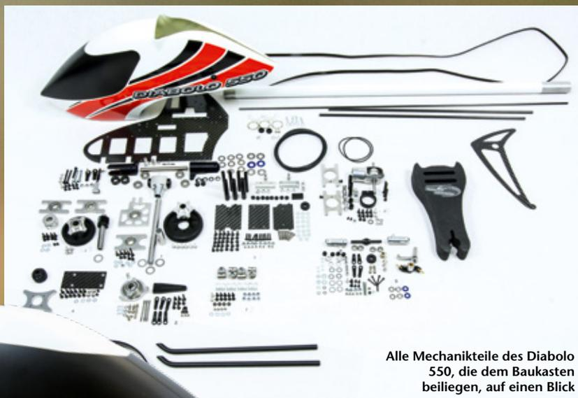
Alle Mechanikteile des Diabolo 550, die dem Baukasten beiliegen, auf einen Blick
