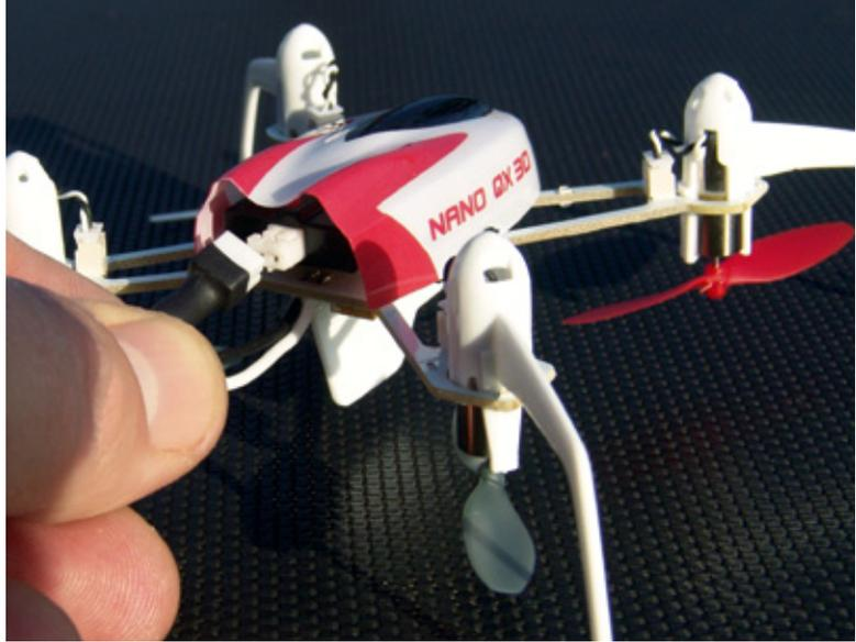
„Hold“-Schalter betätigen. Nach etwas Umgewöhnung – die Drehzahlumkehr erfolgt nicht ganz so schnell wie die Pitch-Verstellung beim CP-Heli – kann der versierte Pilot so auch mit dem kleinen Quad eine ganze Reihe von Kunstflug- und 3D-Figuren in den Himmel zaubern. Der große Vorteil ist dabei, dass der QX 3D aufgrund seines geringen Gewichts und einfachen Aufbaus mit den gesteckten Antriebsmotoren und -halterungen sehr crashfest ist.
