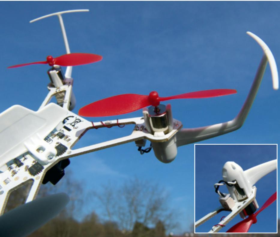
Deutlich zu erkennen ist die Klemmbefestigung der Motoren, die dank des Anschlusssteckers schnell gewechselt werden können. Sehr praktisch sind die Bumper an den Enden der Auslegerarme, mit denen die Props vor Berührung geschützt werden
