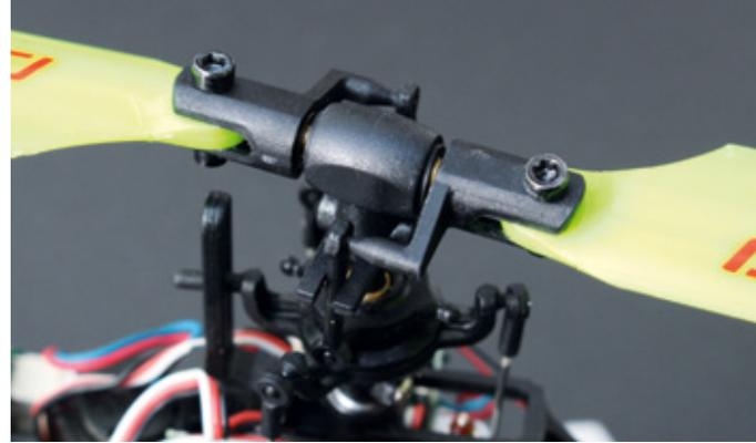
Der Flybarless-Hauptrotorkopf aus Kunststoff ist leicht und stabil aufgebaut. Die Rotorblätter sind sehr weich und ebenfalls nicht kaputt zu kriegen
