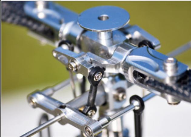
Ist bei einer solchen Rotorkopf-Konstruktion der Blattverstellarm krumm, muss der gesamte Blatthalter getauscht werden. Beim Check sollte man auch keinesfalls vergessen, die Schrauben der Mischhebel zu prüfen, die nach einem Absturz gerne krumm werden können
