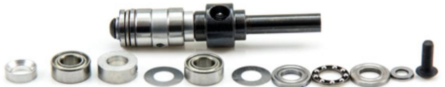
Detailansicht der Heckrotornabe mit allen nötigen Lagern
