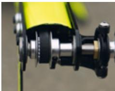
Die doppelt kugellagerte Heckrotorwelle nimmt auch das Alu-Zahnriemenrad auf. Die Pitch-Schiebehülse wird doppelt geführt
