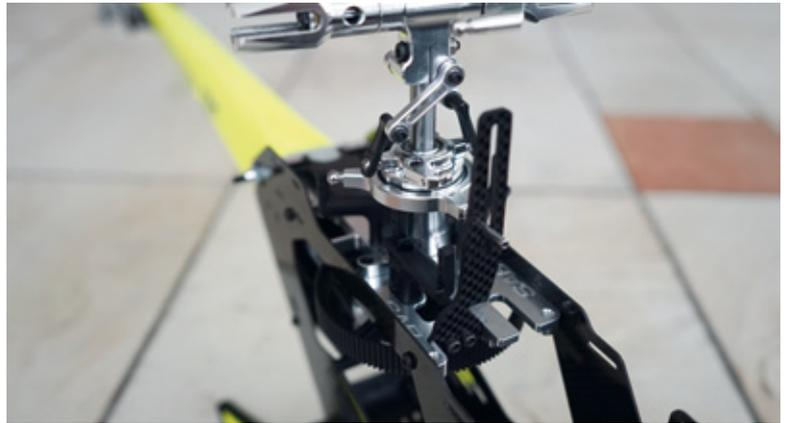
Enorm stabil wird die gesamte Einheit, wenn das Ganze mit den CFK-Seitenteilen verschraubt ist
