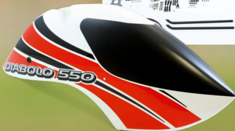
Die fertig beklebte Kabinenhaube des Diabolo 550 hat zwei mit Gummitüllen versehene Befestigungsbohrungen
