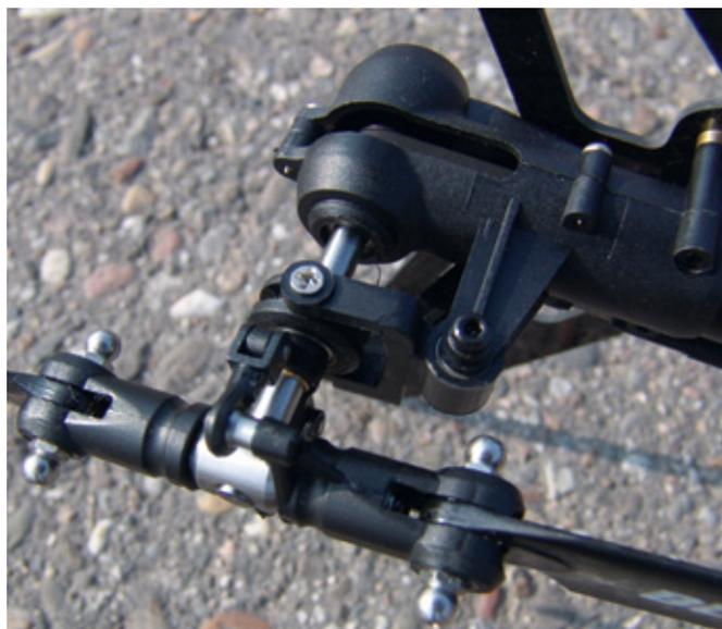
Blade-typisch ist die Heckrotor-Konstruktion mit Kunststoff-Blatthaltern und Propeller-Momentgewichten. Die Kontrolle der Riemenspannung erfolgt über die geschlitzte Öffnung im Heckrotorgehäuse
