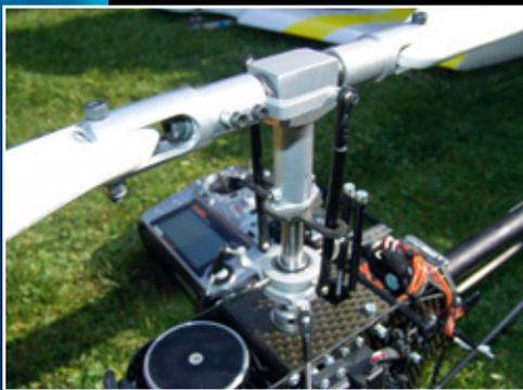
Mit dem bloßen Auge ist nicht erkennbar, ob die Verstellarme beider Blatthalter gleichen Abstand zum Rotorkopf-Zentralstück haben. Im Zweifelsfalle sollten diese demontiert und fluchtend übereinander gelegt werden, um eventuelle Differenzen feststellen zu können
