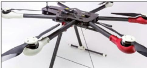
Durch die matte Oberfläche werden Spiegelungen bei Videoaufnahmen auf ein Minimum reduziert.
