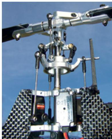
Die Mitnahme des Taumelscheiben-Innenrings erfolgt über kugelgelagerte, am Zentralstück montierte Alu-Arme
