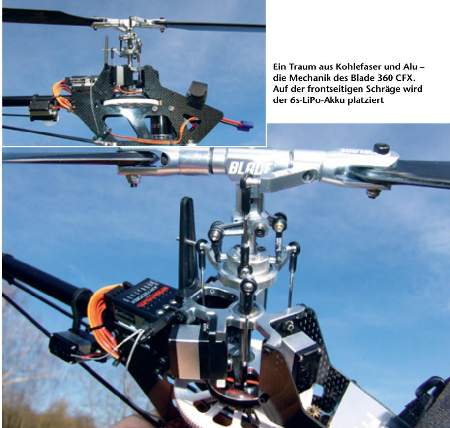
Ein Traum aus Kohlefaser und Alu – die Mechanik des Blade 360 CFX. Auf der frontseitigen Schräge wird der 6s-LiPo-Akku platziert
