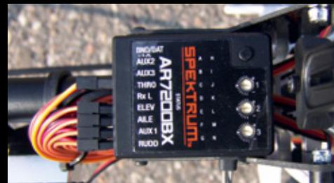
=> Poti 1 ist für die Empfindlichkeit der zyklischen Funktionen verantwortlich. In Richtung plus erhöht man das Einrastverhalten bei zyklischen Befehlen und umgekehrt. Die Werkeinstellung befindet sich hier auf etwa 9-Uhr-Position. Der Heli schwingt nach dem Abstoppen nicht kurz nach.
