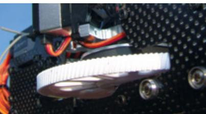
Rolle spielt aber auch der Außenläufer. Während der mit 3s betriebene Blade 450 X V2 eine spezifische Drehzahl von 4.200 Umdrehungen pro Minute und Volt (U/min/V) hat, kommt beim Blade 360 CFX ein Exemplar mit „nur“ 1.800 U/min/V zum Einsatz. Dafür aber besagter 6s-LiPo.
