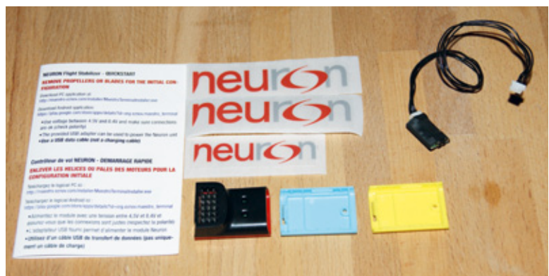
Das Neuron wird mit drei verschiedenfarbigen Bodenplatten, Aufklebern, einer Kurzanleitung für alle drei Software-Versionen und dem USB-Adapter inklusive Anschlusskabel ausgeliefert
