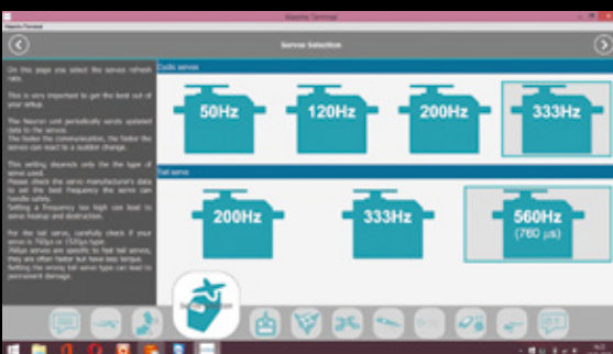
Die Auswahl der Ansteuerfrequenzen für Taumelscheiben- und Heckservo entspricht der der meisten gängigen Systeme
