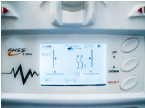
Das LC-Display informiert über die wesentlichen Daten und Einstellungen. Mit den „UP“- und „Down“-Tasten wird der Countdown-Timer gesteuert
