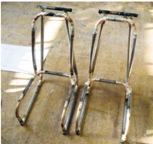
Die Rohrrahmen der Sitze und Sitzbank sind aus dünnwandigem Edelstahl- und Messingrohr hergestellt und hartgelötet. Das Biegen der Rohre erwies sich als sehr schwierig (siehe Text)
