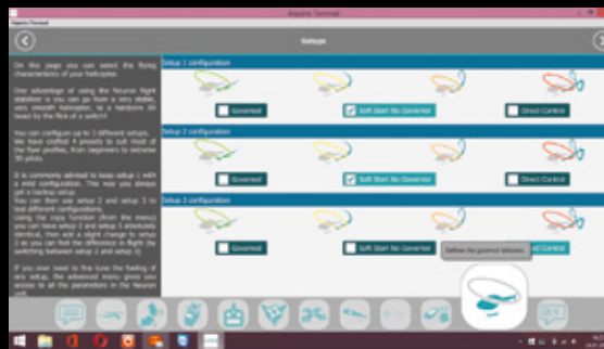
Um sich dem fliegerischen Spektrum des Piloten anzupassen, kann man das Neuron während des Flugs zwischen drei verschiedenen Setups umschalten. Für die Setups stehen jeweils vier verschiedene Voreinstellungen des Flugverhaltens und drei verschiedene Drehzahlregler-Einstellungen zur Verfügung
