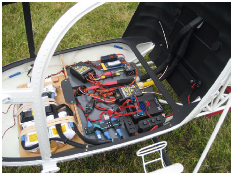
Schön aufgeräumt: All diese RC- und Beleuchtungs-Elektronik-Komponenten inklusive deren Stromversorgung verschwinden später unter dem Cockpit-Boden. Die RC-Platte besteht aus 3 mm starkem PVC
