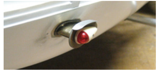
An den stirnseitigen Abdeckungen aus GFK-Material sind „XL“-Highend-Positionslichter mit 1-Watt-Emitter von CS Scale Concepts verschraubt
