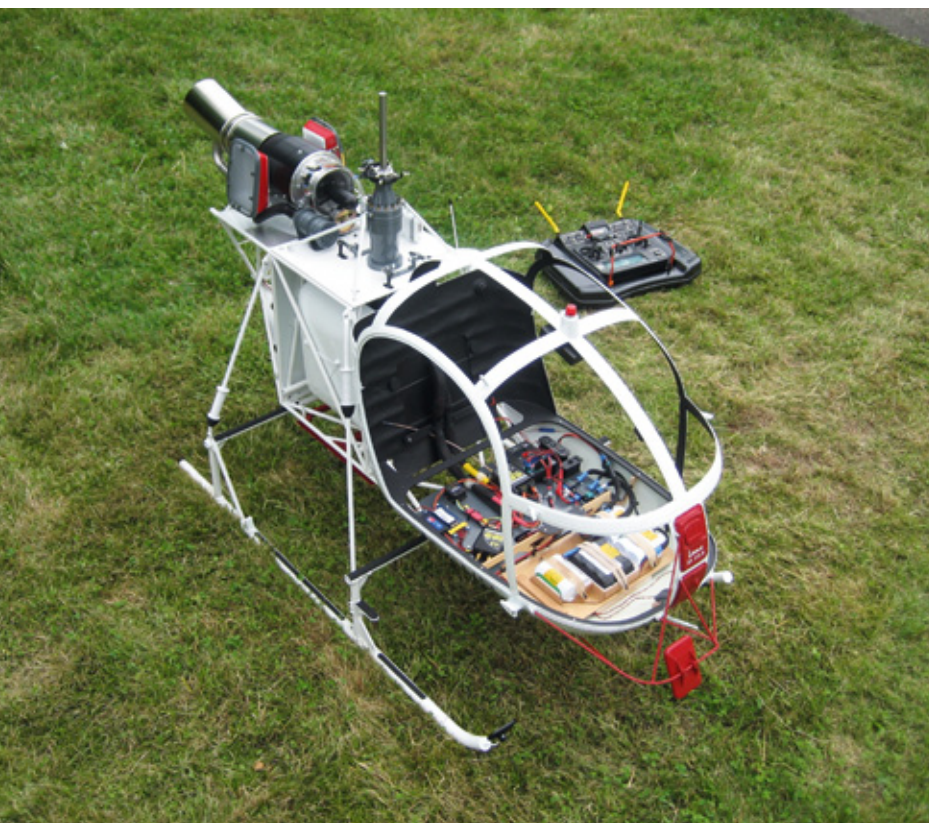
Das rohbaufertige Spiegelgestell nebst Spiegel (wird beim bemannten Vorbild für Außenlasttransporte benötigt). Die Strebenkonstruktion besteht aus 3-mm-Silberstahl
