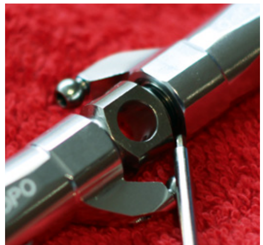
Zwischen Blatthalter und Hecknabe verbaut JR einen kleinen Gummiring. Diese Maßnahme spannt die Blatthalter axial vor und verhindert klackernde Geräusche beim Ausdrehen des Hubschraubers
