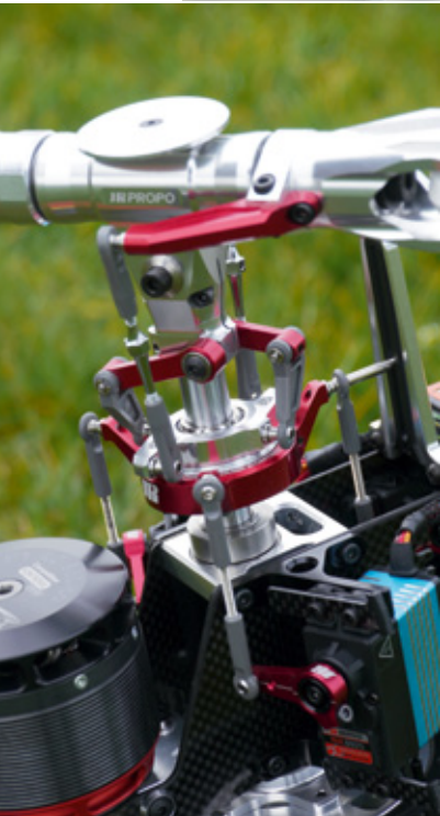
Was gut funktioniert, wird nicht gewechselt: Vom Forza 700 übernommen wurden neben dem Kopf auch die Taumelscheibe mit ihren 120-Grad-Anlenkpunkten sowie die kugelgelagerten Mitnehmerarme
