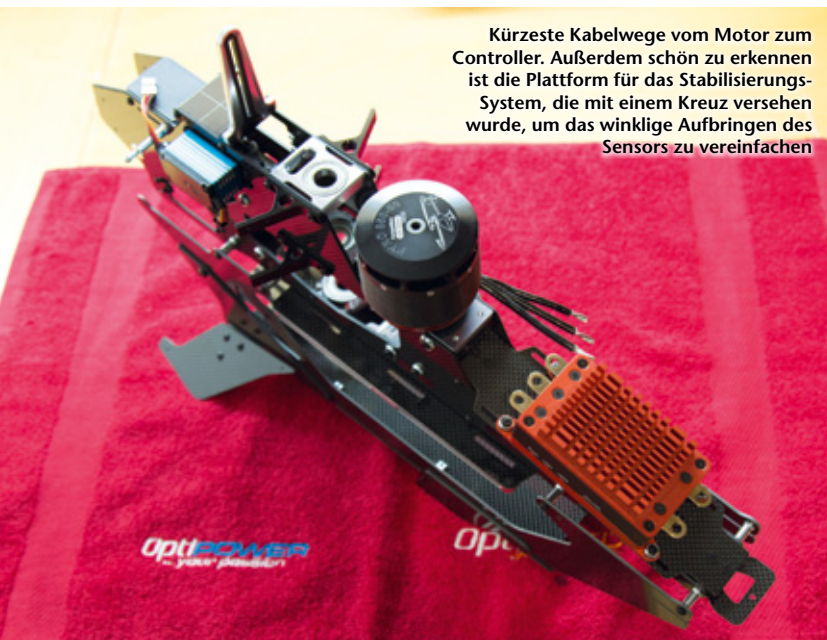
Für den Speedflug nur das Beste: Kontronik-Antriebskombo mit Pyro 850-50 Competition und Kosmik COOL 200HV, im Hintergrund die blitzschnellen JR-Servos
