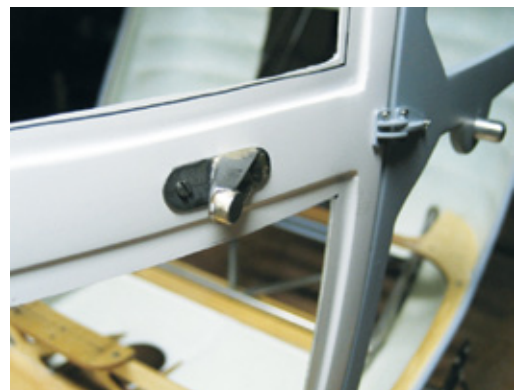
Das sind die Arretierungshalter, mit denen die Türen im vollständig geöffneten Zustand gehalten werden. Diese wurden aus Blechteilen zusammengelötet und mit Magneten versehen
