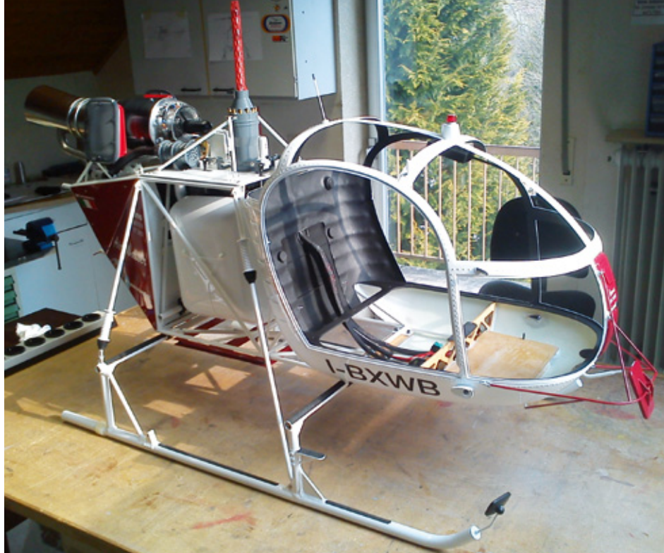
Kanzel-Finish mit Anti-Kollisionsleuchte und der Antenne auf dem Dach. Der kleine Spiegel im rechten Kufen-Rohr ist für die Beobachtung des Lasthakens
