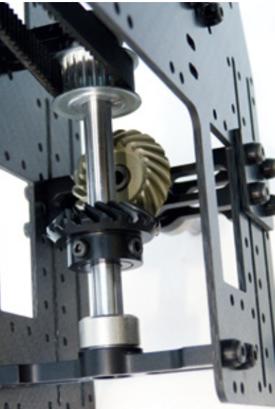
Auf der vom Zahnriemen-gelege angetriebenen Welle sitzt das Kegelaradgetriebe für den Heckrotor-Starrwellen-antrieb. Die Höhe des Abtriebs lässt sich beliebig verschieben; im Chassis befinden sich entsprechende Langlöcher
