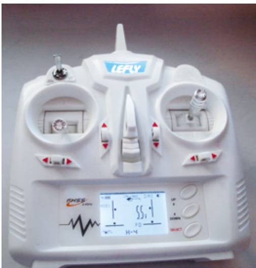
Der handliche und präzise 2,4 Gigahertz-Vierkanal-Sender mit LC-Display
