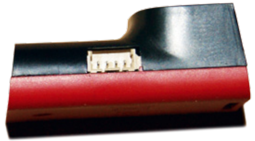
Auf der rechten Seite wird der USB-Adapter für die Programmierung des Neuron via PC angeschlossen
