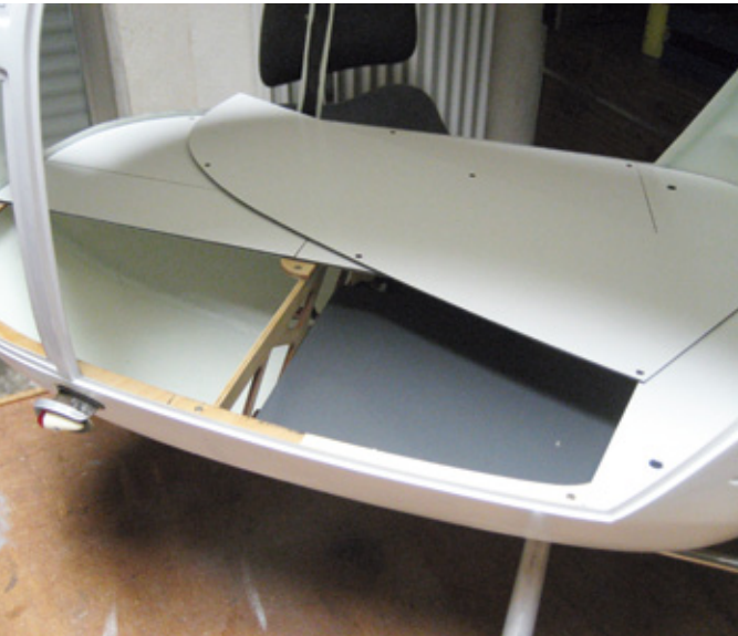
Der leicht herausnehmbare Cockpit-Boden ist vierteilig und besteht aus 2 mm starkem Dibond-Material. Die beiden mittleren Teilstücke bleiben verschraubt
