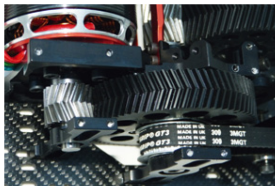
Erste Getriebestufe mit Pfeilverzahnung, die aus jeweils zwei aufeinandergesetzten, schrägverzahnnten Rädern bestehen. Besonders stolz ist unser englischer Autor Jon Tanner auf den Zahnriemen „Made in UK“
