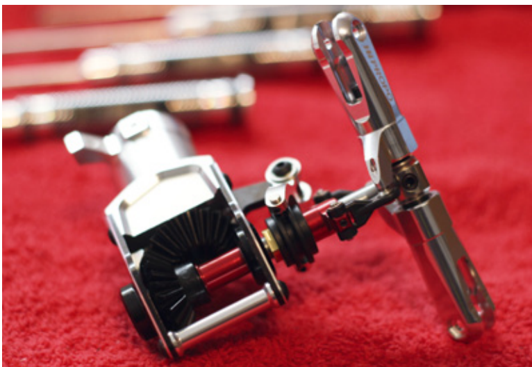
Spielfreie Scherenarm-Anlenkung, hohe Passgenauigkeit und eine neue, einteilig gefertigte Heckwelle. Die Heckeinheit ließ sich in wenigen Minuten montieren
