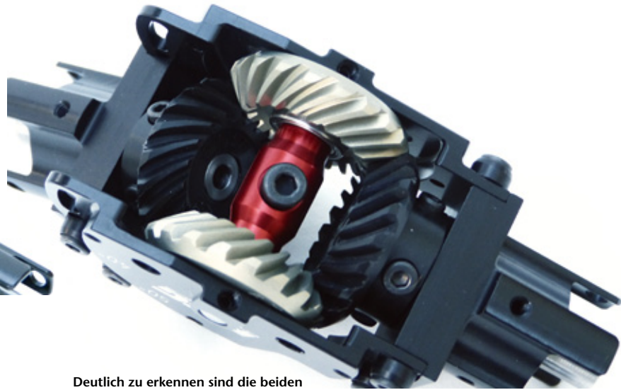
Deutlich zu erkennen sind die beiden palloidverzahnten Kegelräder von Ein- und Ausgangswelle, die über die Kegelräder der Zwischenwelle angetrieben werden
