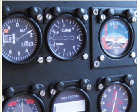
Alle Bohrungen für die scheinbare Verschraubung der Instrumente wurden mit Mikro-Schrauben aus Edelstahl versehen
