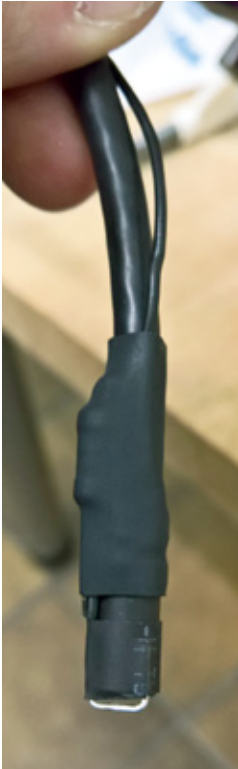
Abbildung 3: Nach einem Test wurde der Widerstand mit Heißkleber gegen Verrutschen gesichert und schließlich alles mit einem Schrumpfschlauch überzogen
