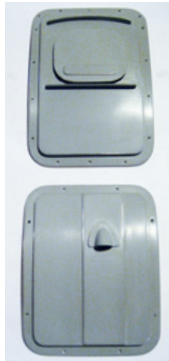
Die selbstgefertigten Wartungsdeckel ganz vorn auf der Haube wurden aus Alu-Blech gefertigt und mit Schlitzschrauben M1,2 an der Kanzel verschraubt
