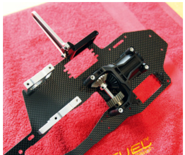
Die Lagerböcke sitzen hier nur lose, genauso wie das Winkelgetriebe. Das vordere Kegelrad ist nun beim Forza SPEED in Stahl ausgeführt
