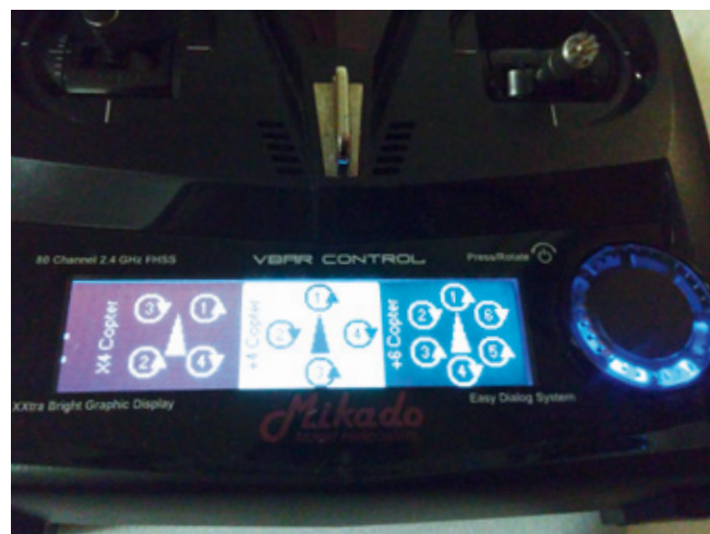
Extrem platzsparend – das VStabi Neo VLink mit aufgespielter VCopter-Firmware, was das Gerät zu einer vollumfassenden Flight-Control nebst integriertem Empfänger macht
