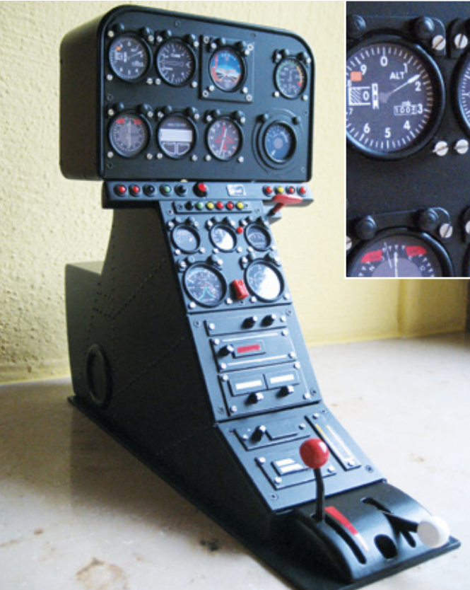
Alles selfmade! Die Frontplatinen zur Aufnahme der verschiedenen Instrumente und Gerätschaften sind aus GFK-Plattenmaterial hergestellt. Für die Lampenleiste kommen zweckentfremdete Ader-Endhülsen aus dem Elektrobereich und Stecknadelköpfe in der entsprechenden Farbe zum Einsatz
