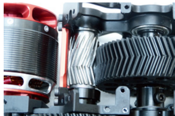
Detail der zweiten Getriebestufe mit der zwischen oberem und unterem Lagerbock befindlichen Ritzelwelle
