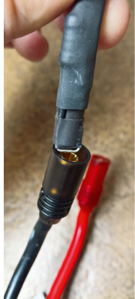
Abbildung 4: Beim Anstecken wird automatisch der Kontakt mit dem Ladewiderstand hergestellt
