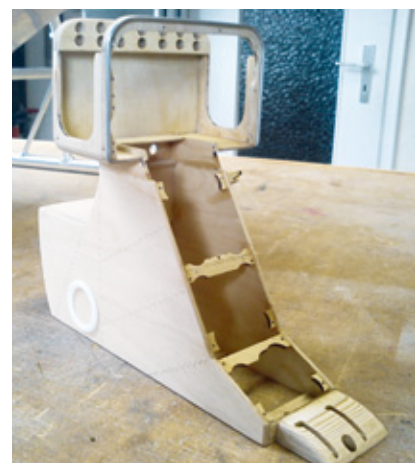
Der gesamte Instrumentenpiz wurde aus Flugzeugsperrholz aufgebaut ...
