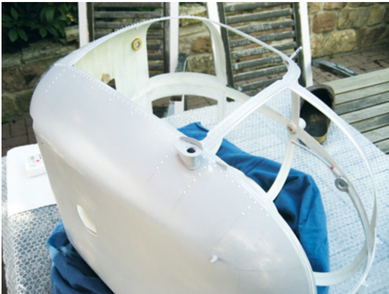
Für die Positionslampen wurden aus Edelstahlrohr Tropfenprofile geformt und auf jeder Seite in die Kanzel eingepasst
