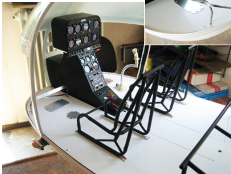
Am Cockpit-Boden wurden noch Deckel, Schutzbügel, Heckrotor-Pedale und natürlich Pitch- und Steuerknüppel aus unterschiedlichen Materialien gefertigt und montiert
