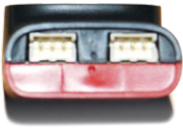
Die beiden Anschlüsse an der Hinterseite des Neuron dienen zum Anschluss eines Spektrum-Satelliten und des Sensors für den Drehzahlregler
