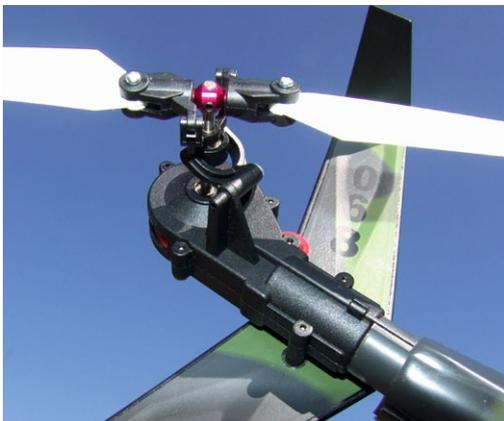
Am den beiden Heckrotor-Kunststoff-Formteilen ist auch das Seitenleitwerk verschraubt. Für das Heckgestänge gibt es sogar eine Führungsöse
