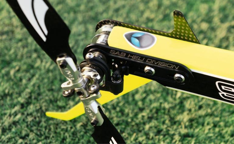
Die Riemenspannung kann durch Verschieben der Heckrotoreinheit justiert werden
