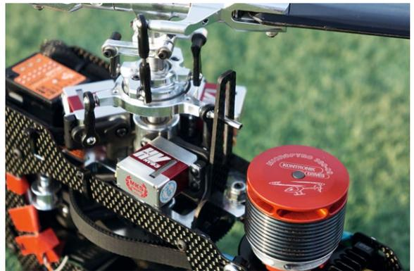
So ist die Taumelscheiben-Anlenkung realisiert. Ganz hinten ist das microbeast erkennbar
