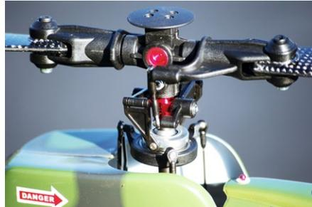
Das Rotorkopf-Zentralstück ist mit einer Alu-Buchse versehen, an der auch die beiden Mitnehmer-Arme verschraubt sind
