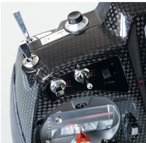
Die Schalter sind bereits serienmäßig eingebaut und können via Software frei zugeordnet werden
