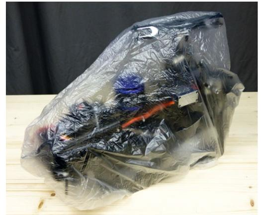
Eingepackt: Um die Mechanik vor Fusseln und die Wäsche vor dem Schmutz der Mechanik zu schützen, wird sie in eine Plastiktüte gesteckt
