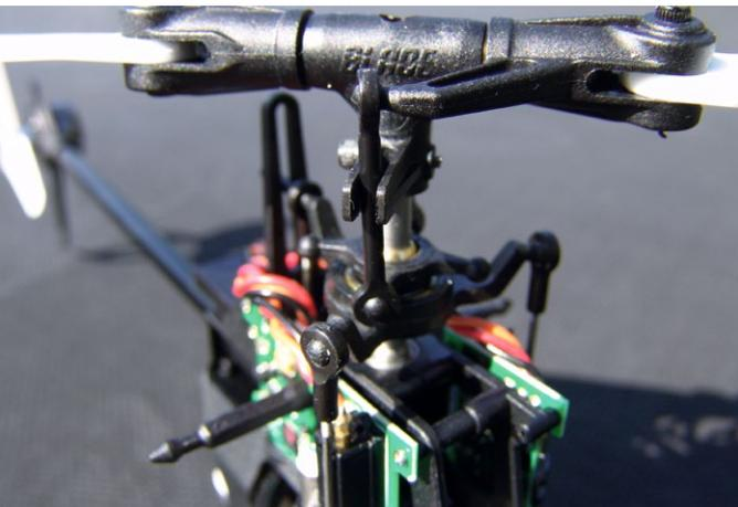
Die Blatthalter werden von vorne angelenkt, wobei Doppelkugelgelenke verwendet werden. Die Mitnahme erfolgt über am Zentralstück angebrachte Gabelführungen
