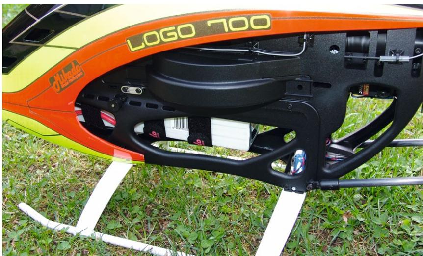
Auch bei montierter Haube wirkt das Chassis nun wie aus einem Guss, das Getriebe ist vollständig gekapselt
