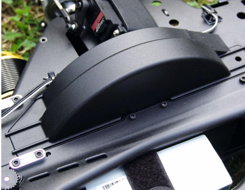
Die Getriebe-Abdeckung dichtet auch auf der Zahnrad-Unterseite vollständig ab
