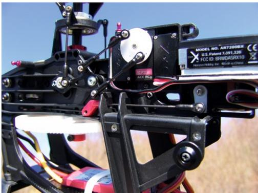
Das rechte Rollservo mit seiner Push-Pull-Anlenkung. Darunter ist liegend das Heckservo untergebracht
