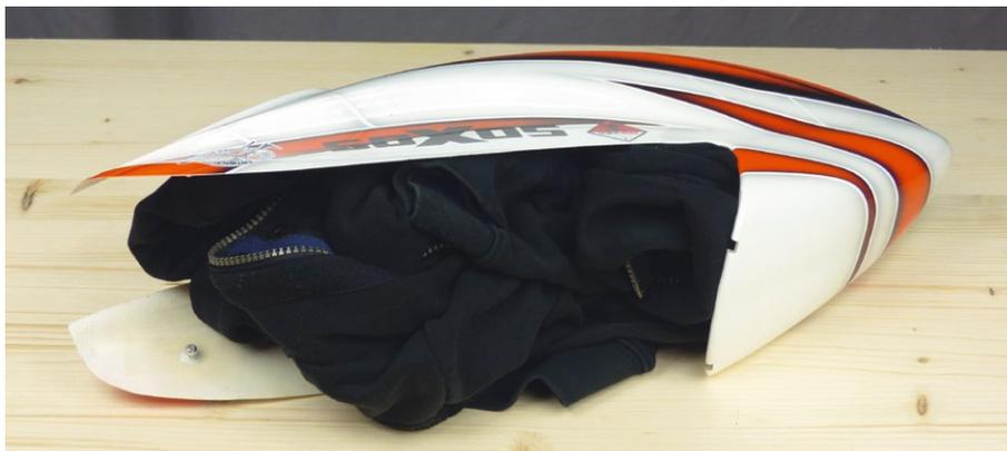
Die Kabinenhaube stopft man fest mit Kleidung aus, um sie bei äußerem Druck vor dem Kollabieren zu schützen. Ein zusammengewickelter Pulli eignet sich optimal. Bei innen stark verschmutzten Hauben kann man die Kleidung noch mit einer Tüte schützen
