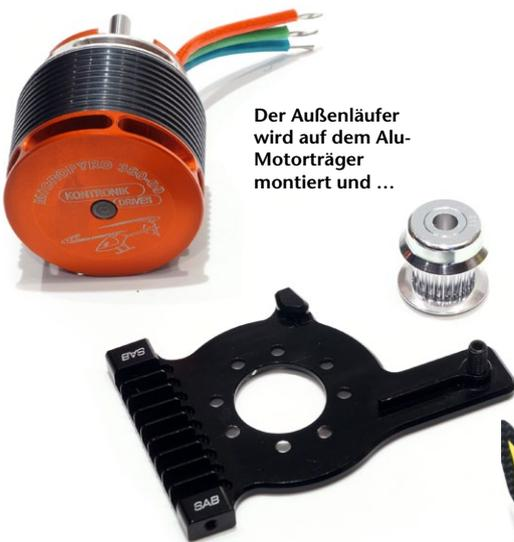
Der Außenläufer wird auf dem Alu-Motorträger montiert und ...
