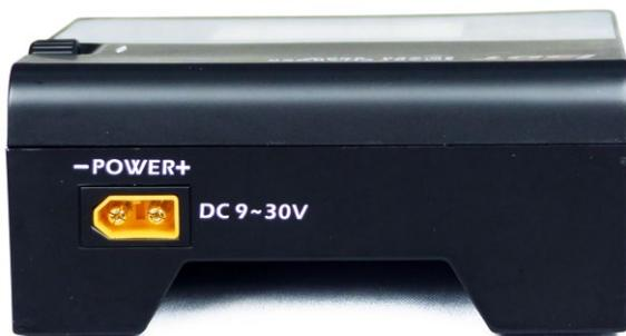
Auf der Rückseite findet man nur den XT60-Anschluss für die Versorgungs-Spannung
