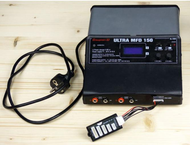
Für das Laden am Urlaubsort eignet sich ein kompakter Lader mit integriertem Netzteil, wie beispielsweise dieses Graupner Ultra MFD 150, das 6s-Akkus mit bis zu 15 Ampere lädt
