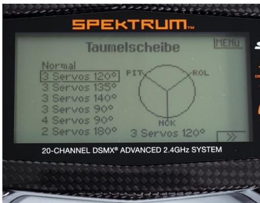
Die DX20 bietet zahlreiche elektronische Taufelscheiben-Mischer. Blättert man innerhalb des Menüs eine Seite weiter (Pfeile unten rechts), lässt sich die Pitch/Gas-Funktion reversieren (Leerlauf vorne)
