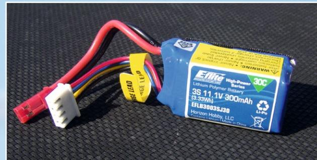
300 Milliamperestunden Kapazität hat der kleine 3s-LiPo, was Flugzeiten um die fünf Minuten ermöglicht
