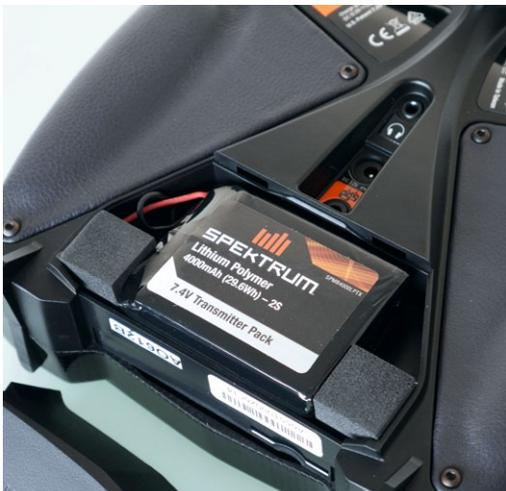
Lange Betriebszeiten ermöglicht der 2s-LiPo. Im Akkufach befindet sich auch der SD-Kartenslot
