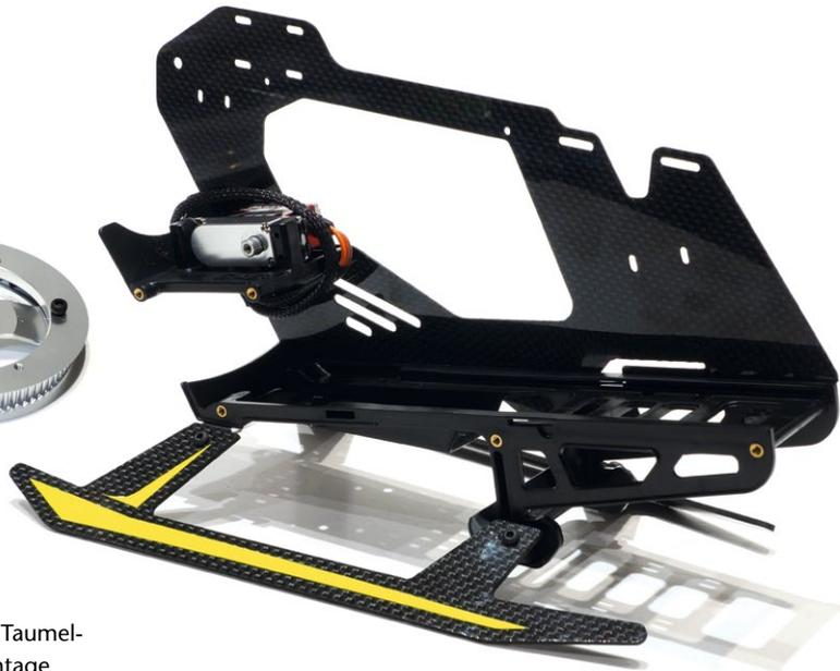
Grundaufbau des Chassis mit Kunststoff-Akkuträger sowie dem innerhalb der Seitenteile platziertem Heckservo. Das Landegestell ist schnittig konstruiert und passt gut zum Gesamt-Outfit
