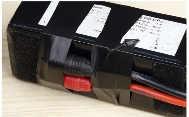
Gemäß IATA-Vorgaben sollen die Anschlüsse von lose mitgeführten Akkus gegen Berührung und Kurzschluss gesichert sein. Hier hat es sich bewährt, die Kabel mit Isolierband am Akku zu befestigen, sodass auch die Kontakte abgedeckt sind
