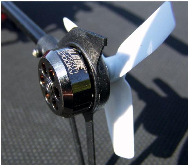
Am Ende des Alu-Heckrohrs sitzt formschlüssig montiert der Brushless-Heckmotor
