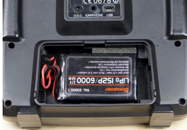
Der Senderakku kann in der Steuerung verbleiben. Diese muss aber gegen versehentliches Einschalten gesichert werden. Am einfachsten steckt man dazu den Akku aus
