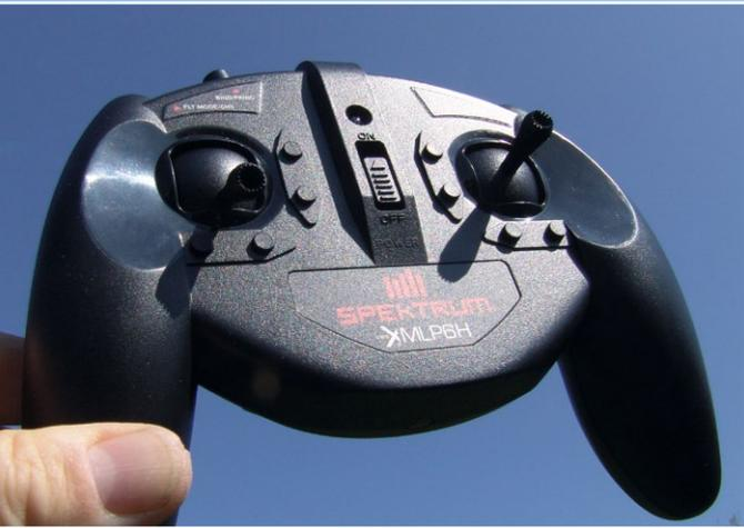
Zum Lieferumfang der RTF-Version gehört auch der Spektrum-Sender MLP6H, der mit allen notwendigen Schaltern ausgestattet ist
