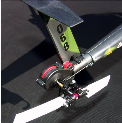
Der Heckrotor mit seinem großen Riemenrad und der Gegen-Andruckrolle beeindruckt durch beste Hochachsen-Performance
