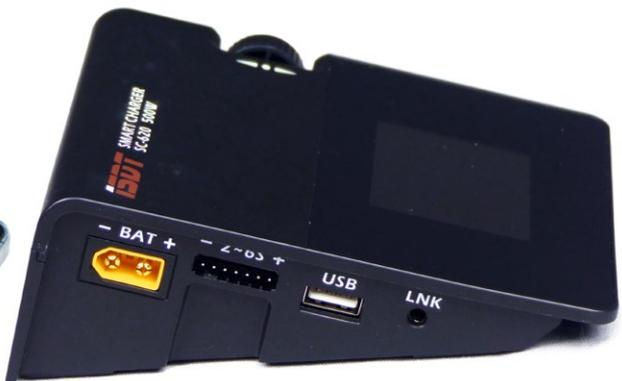
Auf der linken Geräteseite liegen der XT60-Anschluss für den zu ladenden Akku, ein JST-XH-Balancer-Anschluss (universell für 2s bis 6s), der USB-Anschluss und der Link-Anschluss für den PC-Adapter
