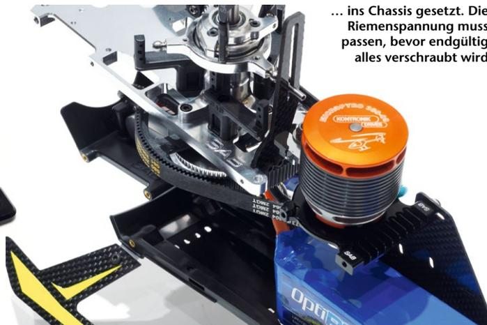
... ins Chassis gesetzt. Die Riemen Spannung muss passen, bevor endgültig alles verschraubt wird
