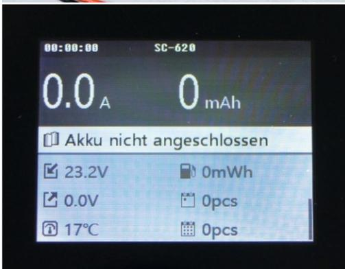
Durch Scrollen nach unten gelangt man immer ins Status-Display mit Informationen zur Versorgungs- und Ausgangsspannung, Temperatur, bisher benötigter Energie und der Anzahl der Ladevorgänge aktuell und insgesamt
