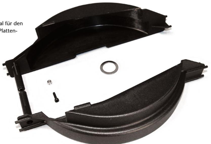
Die Getriebe-Abdeckung für den LOGO 700 besteht aus zwei spritzgegossenen Halbschalen, die miteinander verschraubt werden. Das Gesamtgewicht beträgt 52 Gramm
