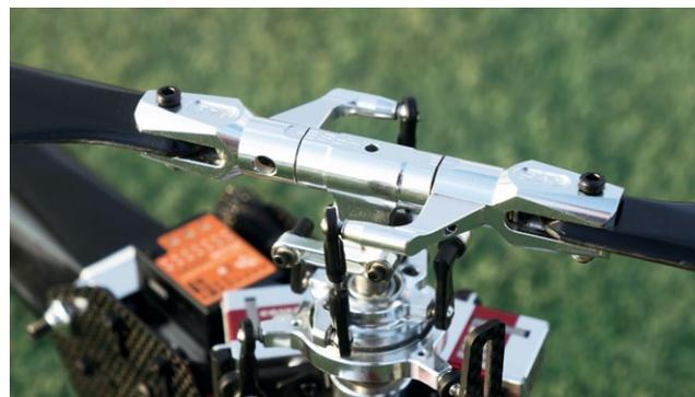
Der Alu-Hauptrotorkopf des Goblin 420. Die Blattstellarme werden mit jeweils nur einer Schraube am Blatthalter montiert
