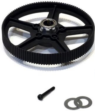
Im großen Hauptriemenrad sind der Freilauf und zwei Radiallager eingelassen. Das Heckrotorantriebs-Riemenrad ist aus Alu gefertigt
