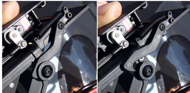
Die Haken schnappen an entsprechenden Chassis-Bolzen ein
