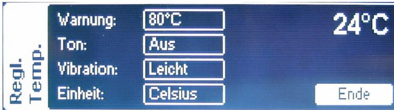
„Regler Temp.“: Die hier einstellbaren Grenzwerte lösen einen Alarm in der VBar Control aus. Die Grenzwerte, die tatsächlich zum Abregeln des Controllers führen, werden im Menü „Abschaltgrenzen“ definiert
