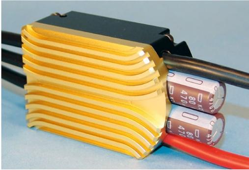
Das Gehäuse des Scorpion Tribunus 14-200A SBEC ist komplett aus Alu gefräst und für die angegebenen Leistungsdaten sehr kompakt. Die Fertigungsqualität ist beeindruckend
