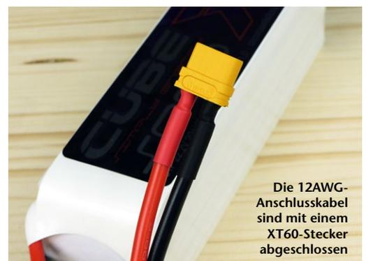
Die 12AWG-Anschlusskabel sind mit einem XT60-Stecker abgeschlossen
