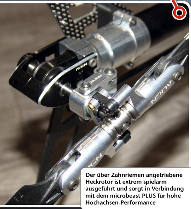
Der über Zahnriemen angetriebene Heckrotor ist extrem spielarm ausgeführt und sorgt in Verbindung mit dem microbeast PLUS für hohe Hochachsen-Performance
