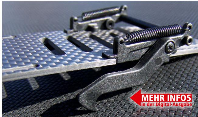
Gut gelöst ist die Arretierung der Akkuplatte mittels dieser Verriegelungs-Mechanik
