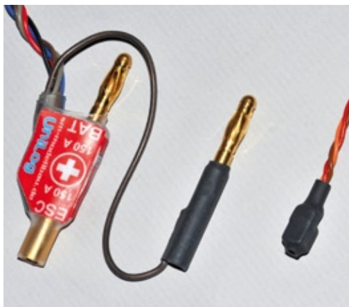
Der weatronic-kompatible SM-Stromsensor bis 150 Ampere, daneben ein externer SM-Tempersensor mit Magnet für Temperaturen bis 125 Grad
