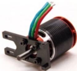
Der auf dem Motorträger montierte Pyro, vorbereitet für den Einbau ins Chassis
