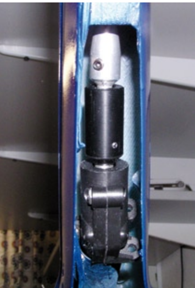
Der Starrantrieb und das Winkelgetriebe werden in das CFK-Außenrohr geschoben
