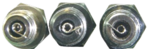
... sondern auch die Dicken und Längen der jeweiligen Wendel, die den Wärmewert bestimmen
