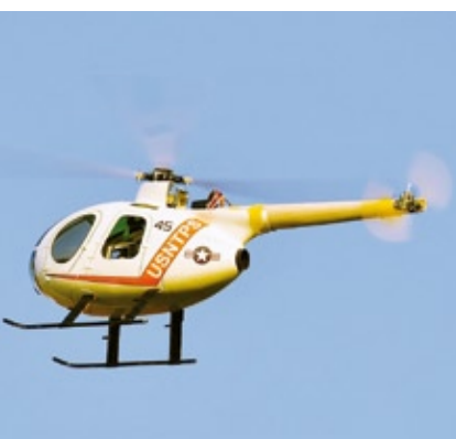
Erstflug mit dem noch „rohen“ Balsa-Heck. Selbst mit einem leichten 1.800er-LiPo passte der Schwerpunkt sofort
