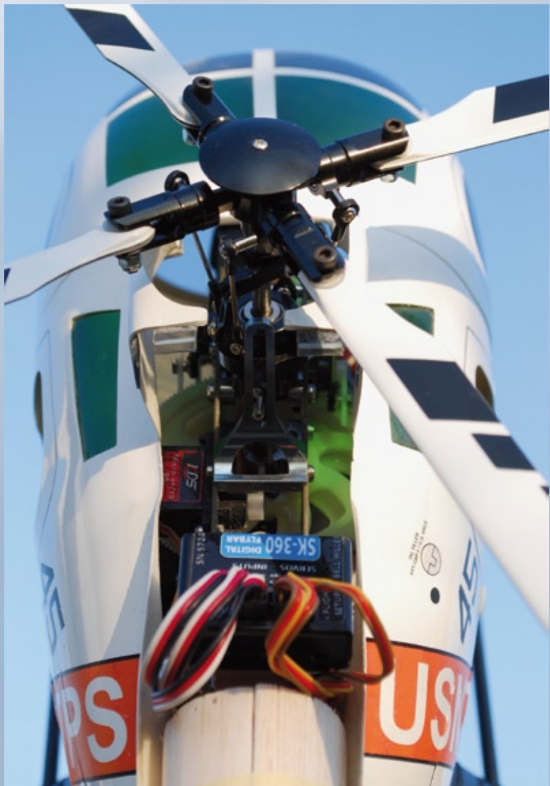
Der Vierblattkopf passt optisch perfekt auf die Cayuse. Dahinter ist das von uns verwendete FBL-System SK 360 erkennbar, das später nach vorne ins Cockpit verlegt wurde
