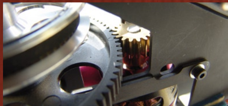
Beim Einstellen des Flankenspiels sollte nicht nur eine Stelle als Referenz genommen werden, sondern das Zahnrad einmal komplett gedreht werden
