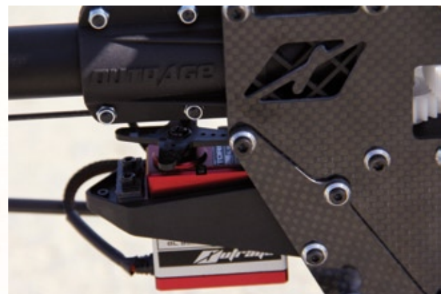
Die Kunststoff-Servoaufnahme fürs Heckrotorservo, die zwischen den Seitenplatten unter der Heckrohrhalterung verschraubt wird
