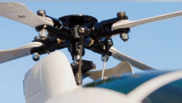
Der montierte Vierblattkopf am Modell. Die beiliegenden Blattschrauben mit Gewinde bis zum Kopf haben wir durch gehärtete M3-Schaftschrauben ersetzt
