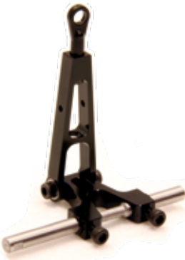
Der Nickhebel, der gleichzeitig den Taumelscheiben-Außenring am Verdrehen hindert
