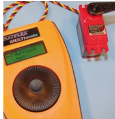
Die Servoparameter der MPX-Digitalservos lassen sich per Multimate verändern. Multimate ist ein universelles Programmiergerät auch für andere MPX-Produkte
