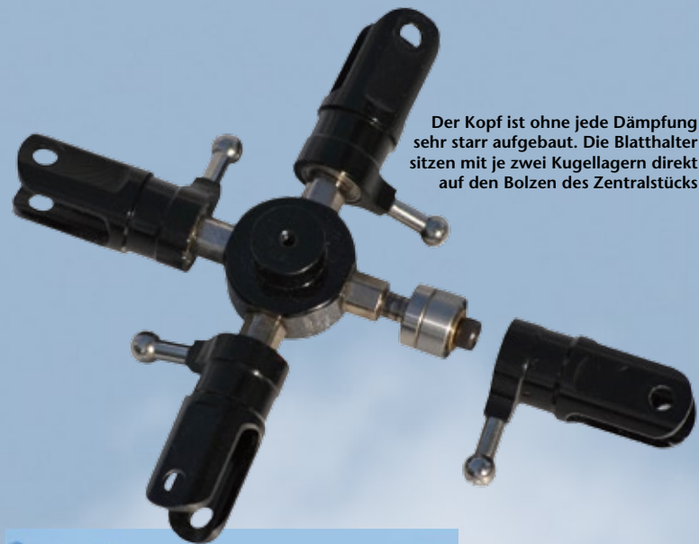
Der Vierblattkopf von rc-toy wird mit Taumelscheibe, Mitnehmer, Steuerstangen und fast allen benötigten Kleinteilen geliefert
