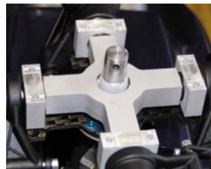
Der in O-Ringen und Kunststoff-Buchsen gelagerte Stern sitzt auf der Rotorwelle
