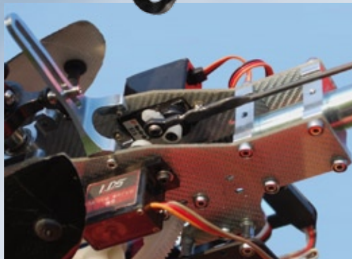
Aus Schwerpunkt- und Platzgründen wanderte das Heckservo vom Heckrohr weiter nach vorne ins Chassis. In der KDS 450C-Mechanik ist an dieser Stelle genug Platz vorhanden
