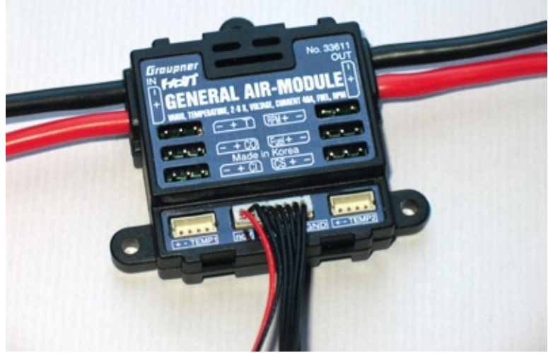
Das General-Air-Modul. Unten links und rechts werden die Spannungs-/Temperatursensoren angeschlossen und in der Mitte ist bereits ein HoTT-Adapterkabel eingesetzt mit einer Steckleiste zum Anschluss des Balancersteckers eines Powerakkus
