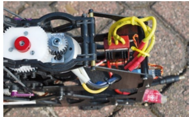
Blick auf die erste Getriebestufe mit der selbstgefertigten Motorbefestigung und den Mädlern-Zahnradern. Deutlich zu erkennen sind die Plättchen zwischen Chassis und Lagerböcken, um die Mechanik insgesamt um 4 Millimeter zu verbreitern
