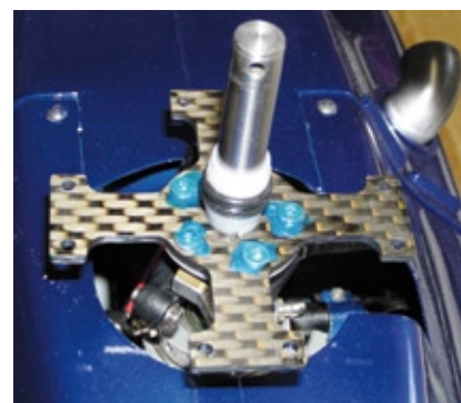
Eine der beiden Kohlefaserplatten, die mit dem Zentralstern verschraubt werden
