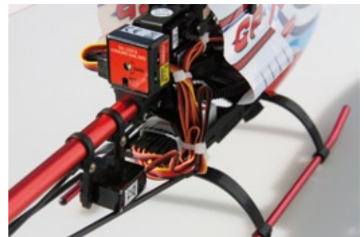
Der Empfänger ist innerhalb des Chassis verstaut
