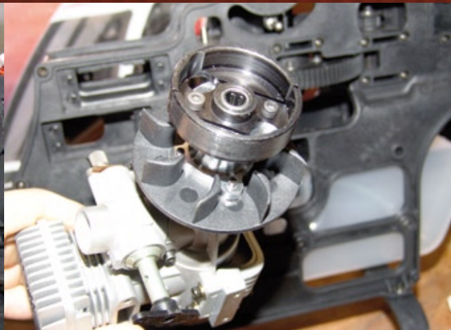
Bei Verbrennerhelis wird meist die gesamte Antriebseinheit – bestehend aus Motor, Kupplung und fallweise Starterwelle – zur Justierung des Flankenspiels verschoben. Dabei ist unbedingt darauf zu achten, dass die Einbauchse der Antriebseinheit mit der des Modells fluchtet
