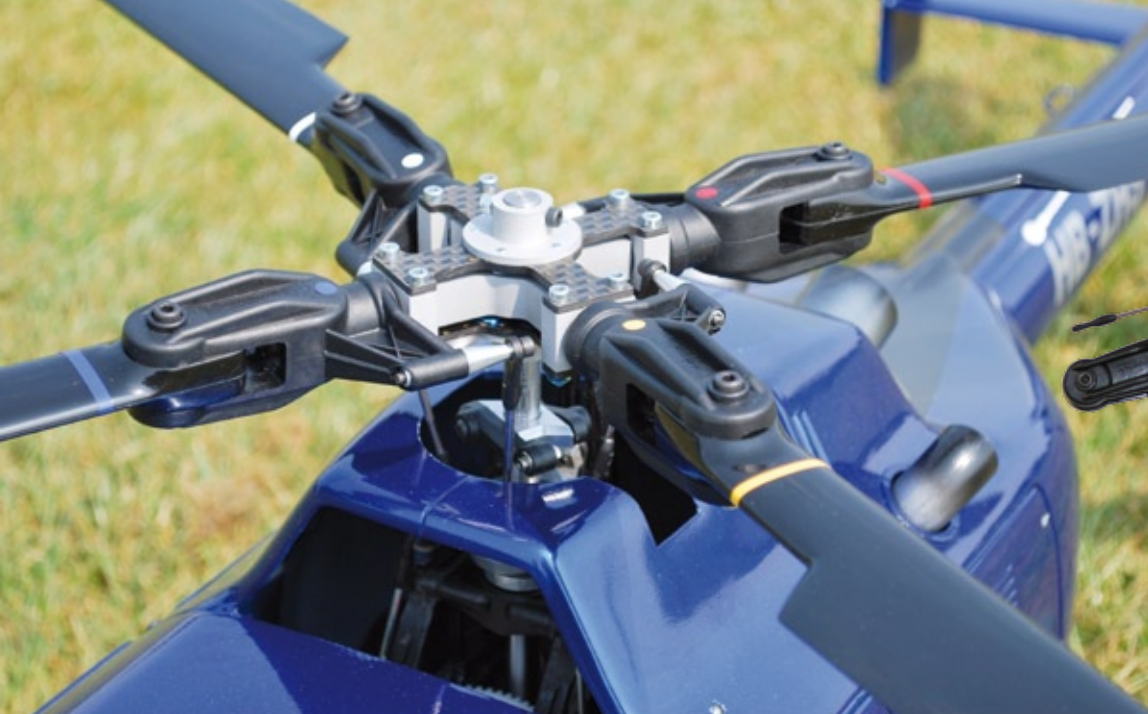
Hier der fertig montierte Vierblatt mit oberer CFK-Platte und Rotorwellen-Verschraubung
