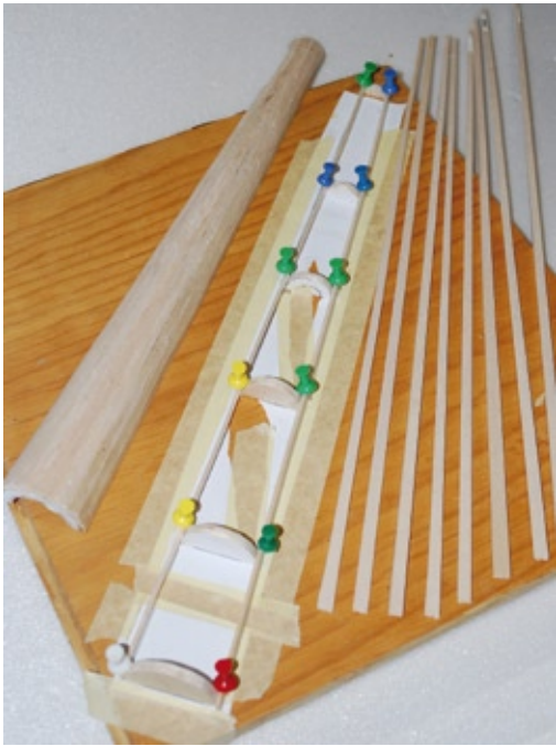
Der neue Heckausleger entstand in traditioneller Balsabauweise und wiegt weniger als die Hälfte des serienmäßigen GFK-Hecks
