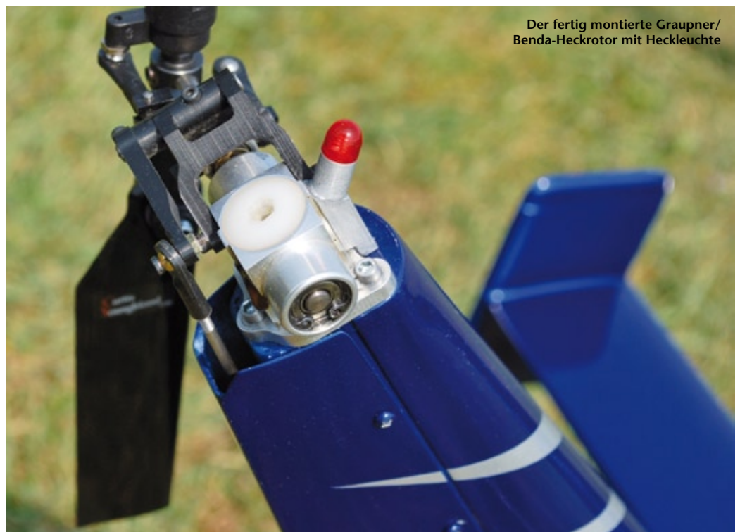
Das Winkelgetriebe wird durch die Rumpfsseitenwand mit einer Schraube befestigt
