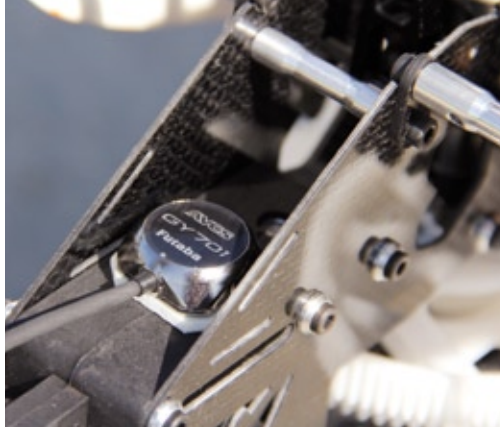
Der winzige Sensor des robbe/Futaba Gyro-Systems GY 701 sitzt unmittelbar auf der Heckrohrlagerung
