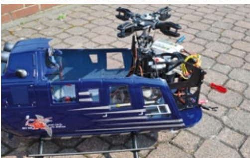
Der Rumpf ist extrem servicefreundlich aufgebaut. In wenigen Minuten lässt sich die Mechanik ausbauen
