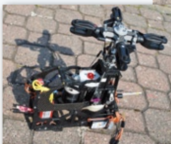
Die auf Elektroantrieb umgerüstete UNI 2000-Mechanik, hier bereits mit dem Vierblattkopf versehen
