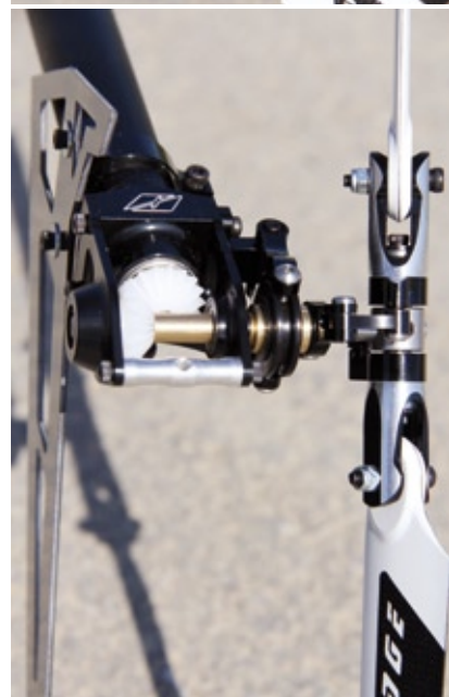
Spielfrei und hohe Performance – der Heckrotor des Fusion
