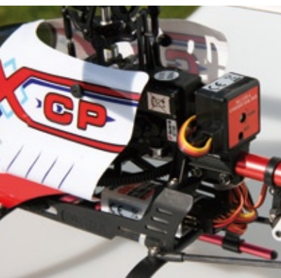
Das Gyro-System befindet sich auf einer Plattform über dem Heckrohr, das Heckservo ist am Heckrohr angeflanscht
