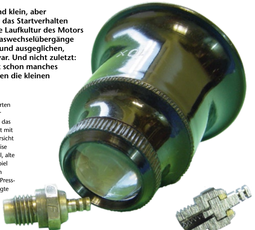
Schnitt durch eine Glühkerze. Durchweg werden hier einheitlich das 1/4-Zoll-Gewinde und ein 8-Millimeter-Sechskant eingesetzt
