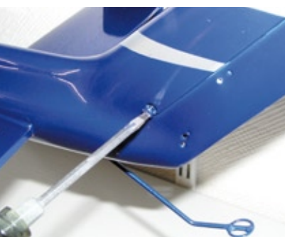
Das Winkelgetriebe wird durch die Rumpfsseitenwand mit einer Schraube befestigt
