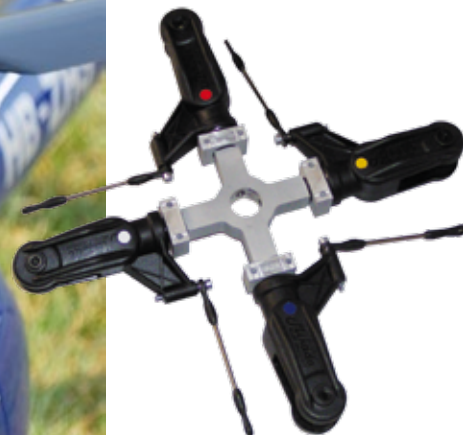
Der Zentralstern des Copterfactory-Vierblattrotors mit montierten Blattlagerwellen und Blatthaltern
