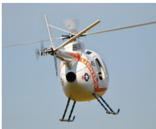
Das auffällige große V-Leitwerk der Cayuse aus Balsa wiegt weniger als ein Drittel des serienmäßigen T-Leitwerks aus Sperrholz
