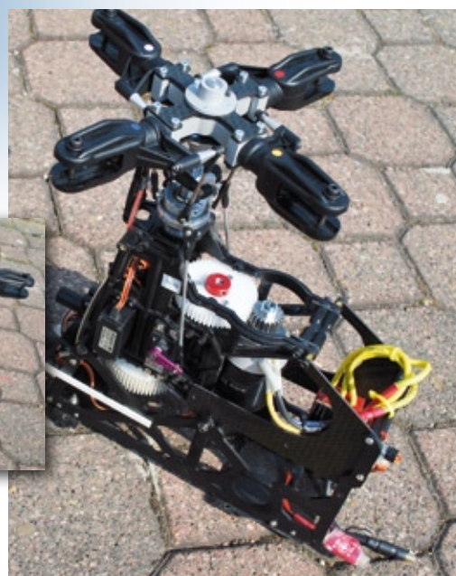
Die auf Elektroantrieb umgerüstete UNI 2000-Mechanik, hier bereits mit dem Vierblattkopf versehen
