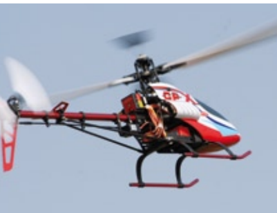
Das Gyro-System befindet sich auf einer Plattform über dem Heckrohr, das Heckservo ist am Heckrohr angeflanscht
