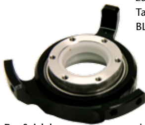
Das Spiel der Taumelscheibe kann durch Anziehen der Schrauben des Innenrings nachjustiert werden
