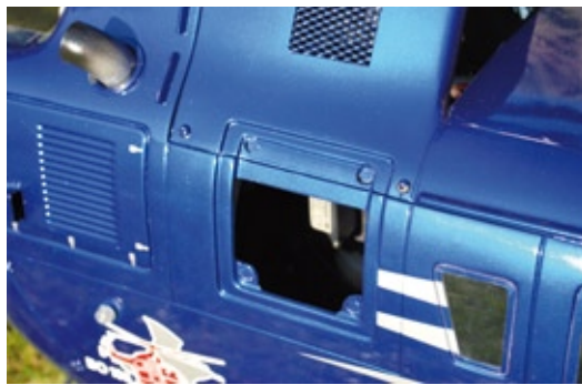
Befestigung des abnehmbaren Seitendeckels mit Hilfe von vertieft eingelassenen Magneten beziehungsweise Magnete am Deckel. Durch die Vertiefungen bleibt der Deckel in genau vorgegebener Position und kann nicht verrutschen
