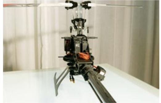
Das stabilere Prepreg-CFK-Heckrohr kommt ohne zusätzliche Abstützung aus. Das Flybarless-System wird später auf der Heckrohr-Klemmung befestigt
