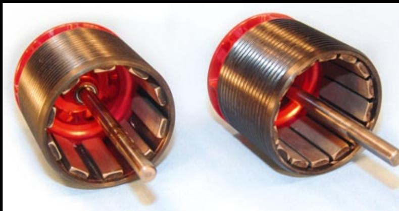
Die Anzahl der Magnete entspricht der Polzahl. Bei diesem Beispiel sind acht Magnete verbaut, also ein Achtpoler
