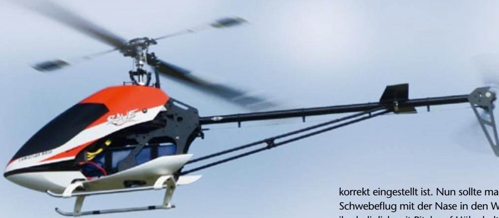
zäh oder fängt der Heli an, über die Funktion Nick (Querachse) zu pendeln oder zu wobbeln? In dies der Fall, ist die Drehzahl noch etwas zu niedrig. Bei zu hoher Drehzahl (ab etwa 1.580 U/min bei der von uns geflogenen Abstimmung) reagiert der Heli auf den zyklischen Funktionen wie auch auf Pitch sehr empfindlich und unruhig. Das Ziel ist, die Drehzahl dahingehend zu optimieren, dass sich der Heli weich steuern und präzise über der gewünschten Position schweben lässt.
