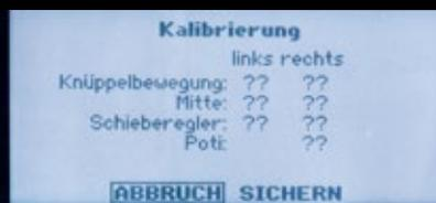
Eine Kalibrierung der Steuerknüppel, Schieberegler und Potis wird von der Software nur bei Umstellung des Steuermodus erzwungen, kann aber auch jederzeit manuell durchgeführt werden
