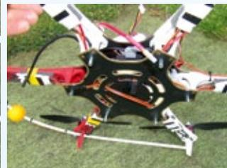
Technik-Details des DJI Hexacopters. Jeder Motor hat seinen eigenen, am jeweiligen Auslegerarm befestigten Controller. Das Konstrukt ist extrem stabil ausgeführt
