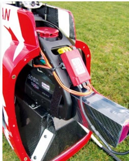
Durch die komplett abnehmbare Haube ist der Zugang zur Mechanik und zum Akkuwechsel absolut perfekt. Selbst das hintere Klettband zur Akkubefestigung ist durch das offene Seitenfenster gut zu erreichen
