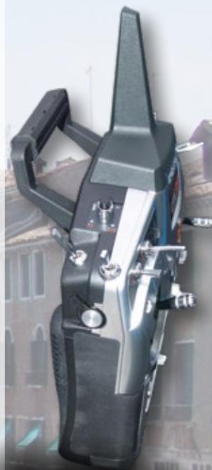
Ganz oben der Drucktaster, der unter anderem auch zum Binden der Empfänger beziehungsweise des Telemetrie-Moduls eingesetzt werden kann. Alle Schalter sind mit Buchstaben beschriftet und lassen sich via Software frei zuordnen
