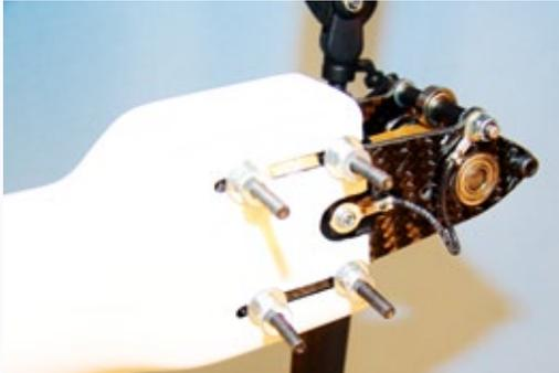
Das Heckrotor-Getriebegehäuse klemmt den Rumpf in Langlöchern. Eine untergeschraubte Litze sorgt für den Potenzialausgleich beim Riementrieb
