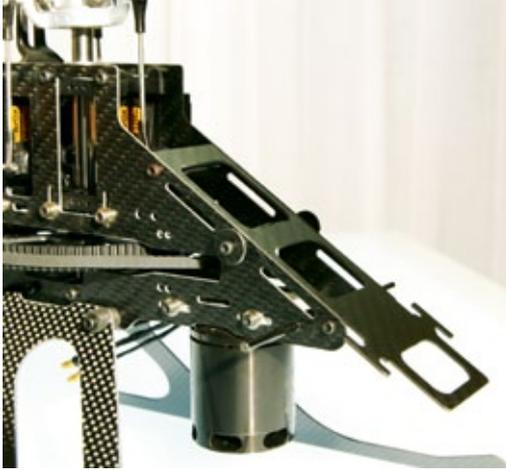
höher belastet und konnte vom MSH-Serienexemplar (CFK-Ausführung) nicht bewältigt werden; es brach während des Flugs. Nach langem Suchen fanden wir einen Hersteller, der ein 17 mm starkes CFK-Heckrohr in den benötigten Abmessungen liefern konnte, das ausreichende Festigkeit aufweist und nur knapp 19 Gramm wiegt.
