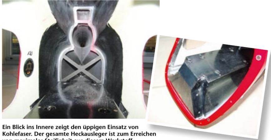
Ein Blick ins Innere zeigt den üppigen Einsatz von Kohlefaser. Der gesamte Heckausleger ist zum Erreichen von maximaler Steifigkeit aus diesem Werkstoff laminiert. Auf einem eingeklebten Kasten aus Kohlefaser wird die Mechanik verschraubt
