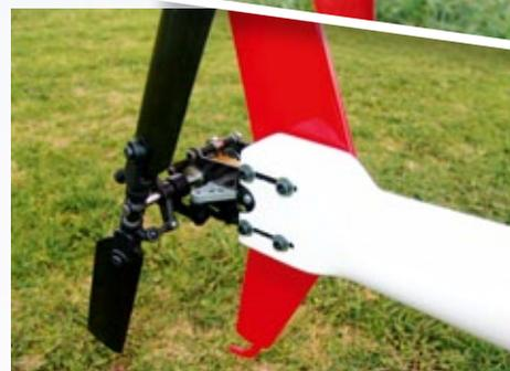
Das T-Leitwerk wird direkt mit den Befestigungsschrauben des Heckrotorgetriebes verschraubt. Die Langlöcher ermöglichen es, den Riemenantrieb korrekt vorzuspanssen
