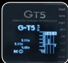
Der Startbildschirm am GT5 zeigt die Empfänger-Akkuspannung und die Ausschläge des Senders sowie die Stellungen der Sensoren
