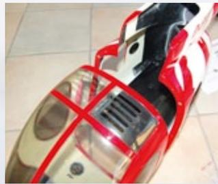
Die rauchfarbene Verglasung ist fertig eingeklebt und mit ausgefrästen Lüftungsschlitzen versehen
