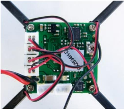
Genial einfach ist die Konstruktion: Es gibt im Wesentlichen nur vier Motoren und eine Platine, auf der sämtliche Elektronik untergebracht ist
