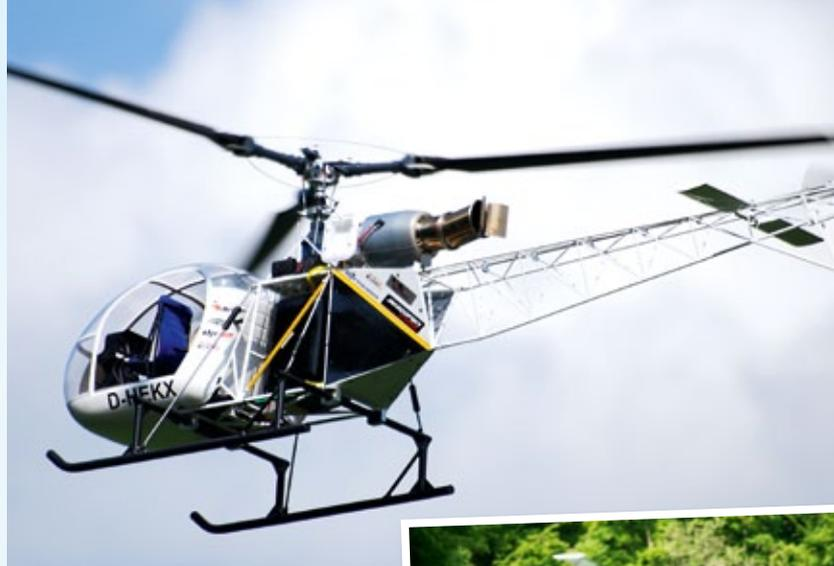
Die neue Lama in der Starwood-Edition im Maßstab 1:5 (Rotordurchmesser 2.300 Millimeter, 17,6 Kilogramm). Besonderheit: Nur noch Turbine und RC-Zubehör müssen zugekauft werden
