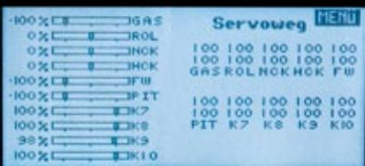
Menü Servowegeinstellung. Ein Servomonitor mit Kanalbezeichnungen ist eingeblendet und hilft bei der Zuordnung
