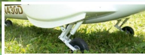
Die phantastisch gebaute und vor allem mit einem hervorragend abgestimmten Elektroantrieb versehene Bell 430 von Stefan Reusch, die von Dave Hollins vorgefliegen wurde. Merkmale: Rotordurchmesser des Vierblatts 2.300 Millimeter, Abfluggewicht 17 Kilogramm, Dreibein-Einziehfahrwerk, Kontronik Pyro 800, Controller Heli jive 120+, Rotordrehzahl etwa 780 Umdrehungen pro Minute, Flugzeit mit 12 LiPos mit 4.500 Milliamperestunden etwa sieben bis acht Minuten (maximale Stromaufnahme nur 50 Ampere)
