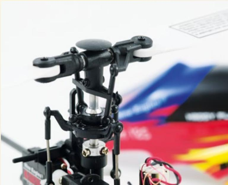
Der Hauptrotor wird mit zwei Gestängen angesteuert, die auch gleichzeitig mit Hilfe der Führung die Taumelscheibe mitnehmen
