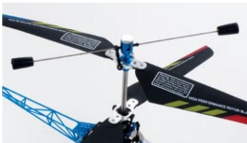
Die Stabilisierungsstange verstellt den zyklischen Pitchwinkel am oberen Rotor so, dass ein Koax extrem stabil fliegt
