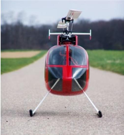
Nach dem Auspacken präsentieren sich die Teile mit makelloser Verarbeitung und einer Lackierung vom Feinsten. Die Kufenrohre sind fertig mit den Bügeln verklebt
