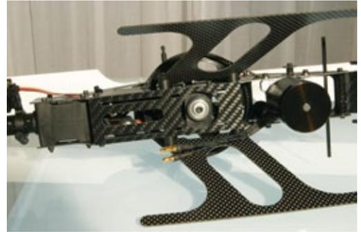
Untere CFK-Chassisplatte mit Blick auf die untere Rotorwellen-Absützung
