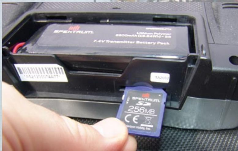
Im Akkuschacht befindet sich der Kartenslot für den Einschub der SD-Karte, mit der sich der Modellspeicher erweitern und ein Software-Update aufspielen lässt
