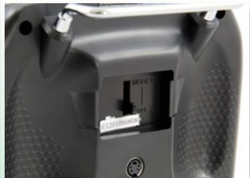
Diese Idee ist genial: Durch Schalterumlegen kann man zwischen Mode 1 und 2 umschalten. Keine weiteren Änderungen sind nötig
