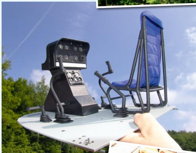
Das komplette Cockpit der Lama kann leicht herausgenommen werden. Sämtliche Elektronik inklusive der Taumelscheibenservos ist im Rumpfbau untergebracht
