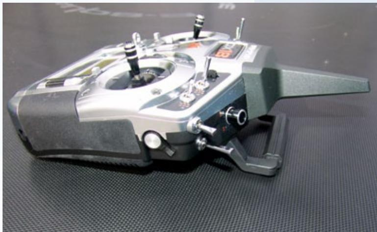
Die Schalter auf der rechten Stirnseite der DX18. Der schwarze Drehregler oben kann einem Proportional-Kanal zugeordnet werden, ebenso der sehr gut mit dem Zeigefinger erreichbare Slider an der Seite
