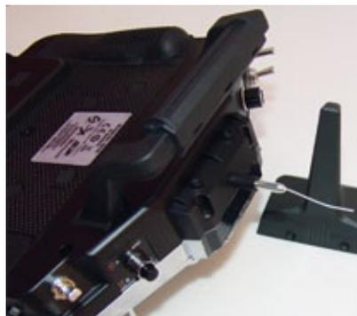
Die DX18 hat zwei Senderantennen: Eine befindet sich senkrecht an üblicher Stelle positioniert (nicht dreh- und schwenkbar), die andere im Kunststoff-Tragegriff auf der Rückseite des Senders
