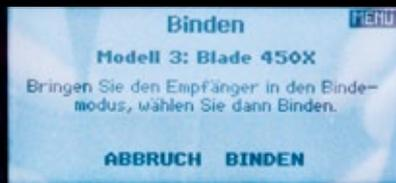
Das Binde-Menü zum Koppeln an Spektrum-DSM2- oder DSMX-Empfänger
