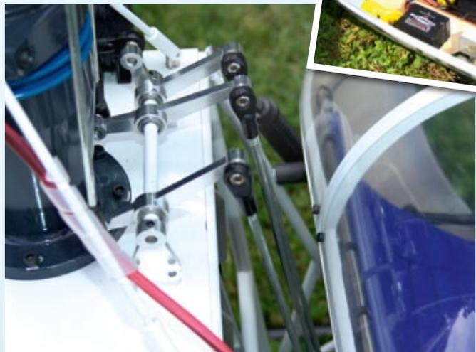
Die Taumelscheiben-Anlenkung erfolgt über Umlenkhebel – wie beim manntragenden Vorbild
