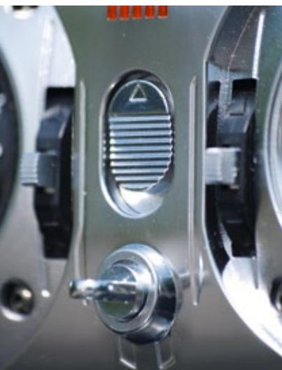
Der Ein-Aus-Schalter ist im Gehäuse versenkt und befindet sich in Sendermitte über der Aufhängeöse
