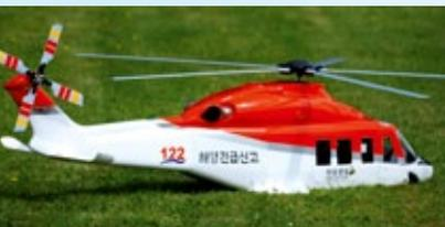
Die neue VARIO Agusta AW 139 im Maßstab 1:7 mit einem Rotordurchmesser von 1.970 Millimeter und Dreibein-Einziehfahrwerk
