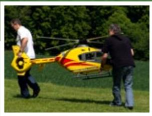
Die EC 135 Big – wahrlich groß mit 2.430 Millimeter Rotordurchmesser und einem Gewicht von 24 Kilogramm. Angetrieben wird das mit Fenestron ausgerüstete Modell von einer JetCat-Zweiwellenturbine SPT5H
