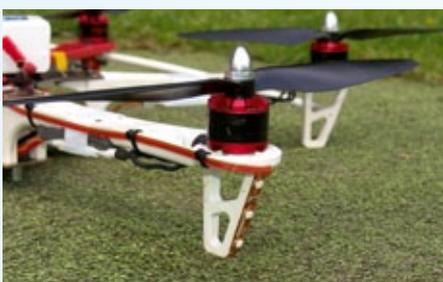
GPS-Unterstützung sorgt dafür, dass die Multikopter ohne Zutun des Piloten eine eingespeicherte Position automatisch beibehalten beziehungsweise wieder einnehmen
