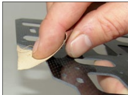
Vor Beginn der Chassis-Montage empfiehlt es sich, alle Kanten der CFK-Seitenteile zu entgraten, weil scharfe Kanten eventuell zu Kabelbeschädigung führen könnten
