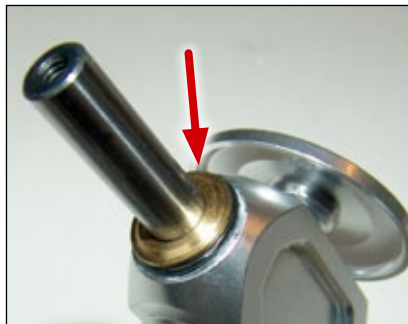
Fertig eingesetzte Dämpfergummis – Zeit für das Auffädeln der Messing-Anlaufscheibe. Der angedrehte Ansatz gehört nach außen, um später am Innenring des Kugellagers anzuschlagen
