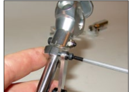
Die kugelgelagerten Mitnehmerarme werden am Zentralstück verschraubt. Die Schrauben sorgen auch für entsprechende Klemmung des geschlitzten Zentralstücks auf der Rotorwelle
