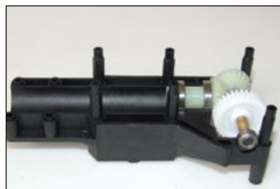
Die Kunststoff-Sechskantbolzen werden in die entsprechenden Bohrungen eingesetzt, bevor man mit der zweiten Gehäusehälfte das Gelege verschließt
