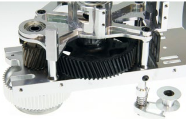
Teilmontiertes Hauptgetriebe. Ganz unten das Zahnriemenrad der ersten Stufe, unmittelbar darunter das Heckabtriebs-Zahnriemenrad
