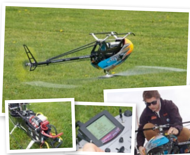
Alexander Schiegg führte spektakulär seinen Compass 7HV Ultimate vor. In der Mechanik sind die schnellen HiTEC HV-Digi-Servos HS-8360TH verbaut, die in Kombination mit dem VStabi für enorme Performance sorgen. Über M-Link-Telemetrie lässt er sich an seiner MPX Royal Profi 16 in Echtzeit unter anderem die verbleibende Restkapazität anzeigen, die ein Stromsensor ermittelt
