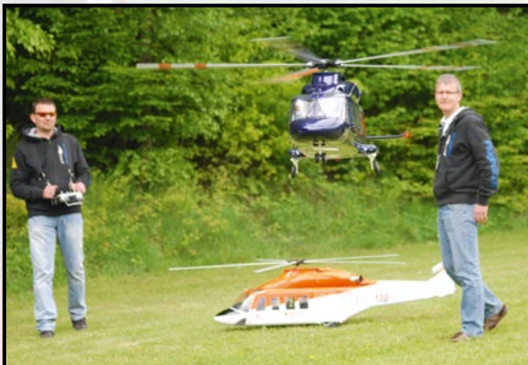
Sowohl für Turbine als auch Elektro-Antrieb – die Vario Agusta AW 139 im Maßstab 1:7 mit einem Rotordurchmesser von 1.970 Millimeter und Dreibein-Einziehfahrwerk
