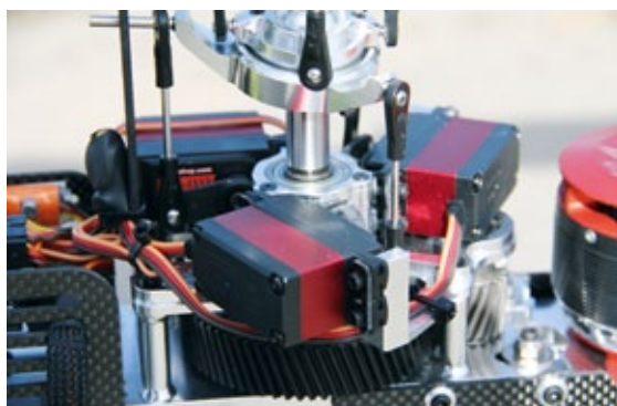
Die Taumelscheiben-Servos sind direkt unterhalb der Taumelscheibe am Domlager befestigt
