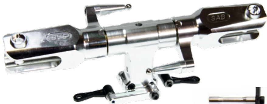
Der Ganzmetall-Hauptrotorkopf mit am Zentralstück montierten Mitnehmer-Armen
