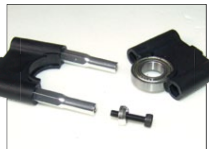
Die Rotorwelle ist dreifach gelagert. Oben und in der Mitte sitzen Alu-Lagerböcke, unten kommt dieses zweiteilige Kunststoff-Exemplar zum Einsatz. Die Verschraubung erfolgt über Sechskanteinsätze und M3-Schrauben
