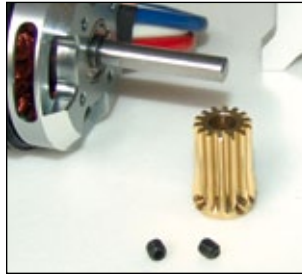
Das zu montierende Messingritzel hat 14 Zähne und wird mit zwei Madenschrauben auf der 6-mm-Welle geklemmt
