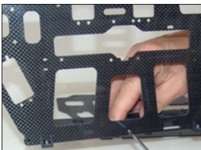
Die untere Kunststoff-Lagerleiste wird mit den Seitenteilen verschraubt
