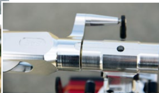
Das Setup wird durch eingravierte Markierungen erleichtert
