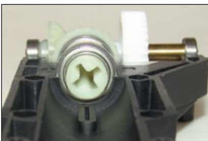
In diese geschlitzte Kupplungs-Aufnahme wird später der Alu-Zapfen der Starrwelle eingeschoben
