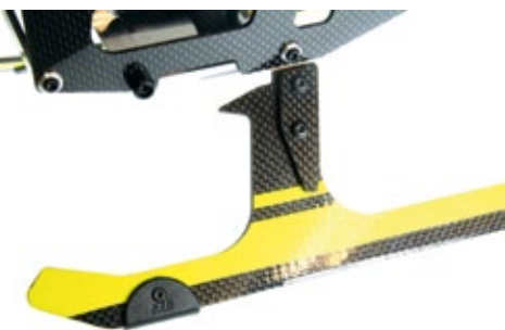
Die CFK-Kufenbügel mit Verstärkungs-Aufdopplung
