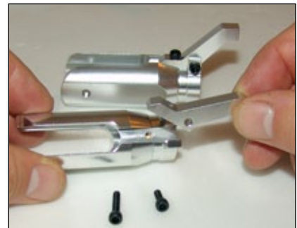
Die Alu-Blattverstellarme werden in den Nuten des Blatthalter montiert. Zuerst mit der kurzen Schraube den Arm bündig und fest anziehen, dann erst die längere M3-Querschraube einsetzen und verschrauben
