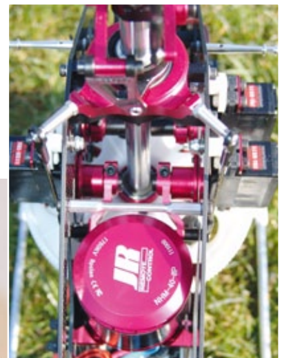
Die Führung der Roll- und Nickhebel erfolgt in mit Kugellagern bestückten Domen an der Innenseite des Chassis. Sie sind mit Schrauben auf den Wellen geklemmt. Die Anlenkgestänge laufen absolut senkrecht nach oben
