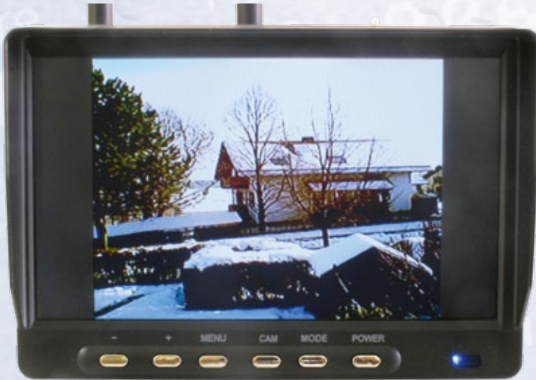
Beispiel für einen größeren Monitor. Das FPV-Bild im Seitenverhältnis 3:4 zeigt die mittlere Qualität des FBAS-Videosignals
