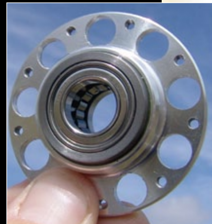
Beispiel einer Metall-Freilaufnabe, die auf dem Hauptzahnrad montiert wird. Das eigentliche Freilauf (Klemmkörper) sitzt in der Mitte der Einheit, die Führung der Welle übernehmen Radiallager
