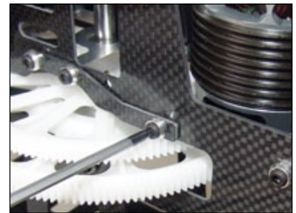
Die zuvor nur handfest montierten Schrauben werden endgültig fest angezogen. Sicherungslack nicht vergessen und auf lotrechte Ausrichtung des Motors achten auf
