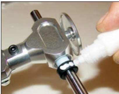
Die Teflon-Anschlaghülse ist mittig auf der Blattlagerwelle platziert und ins Zentralstück eingesetzt, die beiden Dämpfergummis werden mit reichlich Fett aufgesetzt. Fett gehört vorher auch an die Innenbohrung
