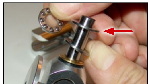
Bestimmen von äußerer und innerer Deckscheibe des Axiallagers durch probeweises Aufsetzen und Schrägstellen auf der Blattlagerwelle. Der kleine Innendurchmesser – die Scheibe, die am wenigstens kippt (Pfeil) – muss bei der Montage nach außen hin gerichtet sein
