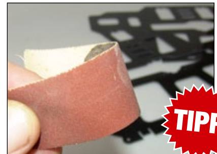
Zum Entgraten nimmt man am besten Schmirgelleinen. Den eigentlichen Arbeitsprozess am besten über einem Waschbecken nass ausführen, um die Werkstatt vor dem schwarzen Schleifstaub zu bewahren
