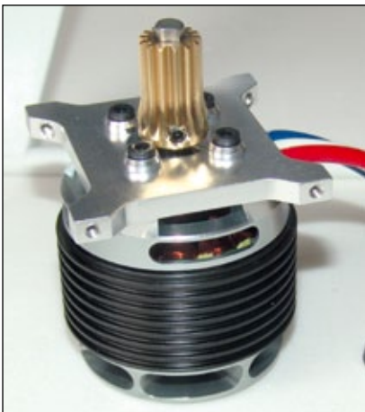
Die fertig montierte Motoreinheit, bereit für die Verschraubung im Chassis
