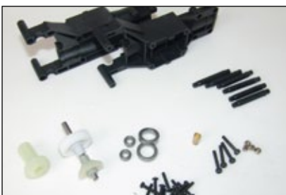
Einzelteile des Heckrotor-Abtriebs am Hauptgetriebe. Da ein Starrwellenantrieb verwendet wird, kommt ein 90-Grad-Kegelradgetriebe zum Einsatz
