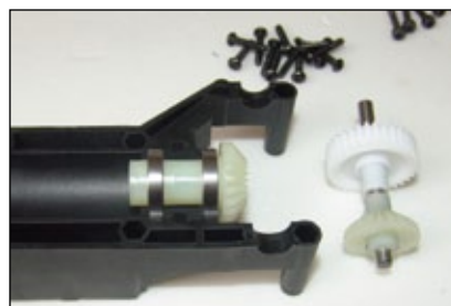
Auf der Welle sind bereits das Ritzel und Kegelrad verpresst beziehungsweise verstiftet. Das erste Kegelrad kann in die Lagerschale eingelegt werden
