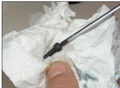
Die M5-Schrauben der Blattlagerwelle müssen sorgfältig chemisch entfettet werden (zum Beispiel mit purem Alkohol), um später dem Sicherungslack beste Basis zu bieten
