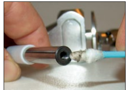
Entfettet ist auch bei den Gewindebohrungen der Blattlagerwelle angesagt
