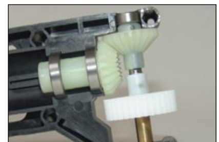
Montage der Getriebeeinheit unter Berücksichtigung von zwei Radiallagern und einer Messing-Distanzhülse. Das Getriebespiel stimmt perfekt und braucht nicht eingestellt zu werden
