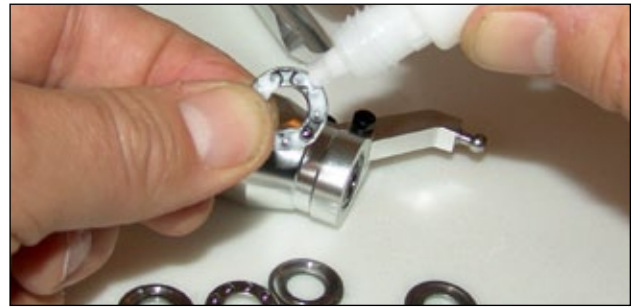
Der Lagerkäfig des Axiallagers muss gefettet werden. Das Fett lässt sich gut in die offene Seite eindrücken, die später so eingesetzt werden sollte, dass sie zum Zentralstück zeigt. So bleibt der Schmierstoff unter Fliehkrafteinwirkung besser in der Wanne haften
