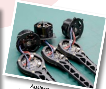
Auslegerarme des S800, die mit Motoren und Controller bestückt werden
