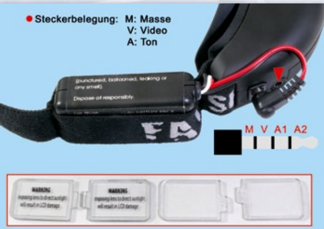
Die Infrarotfilter (links unten) können durch Linsen ersetzt werden
