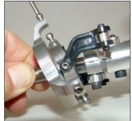
Verbinden der Mitnehmerarme mit dem Taumelscheiben-Innenring – und fertig ist der gesamte Hauptrotormast
