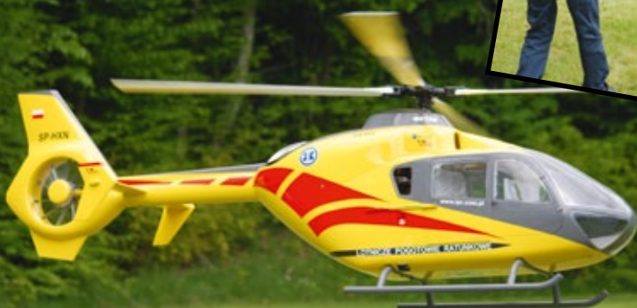
Die große EC 135 (Maßstab 1:4) wird bei Vario nun auch in der Elektro-Version angeboten. Merkmale: Pyro 800, Roxxy-Controller, Zehnblatt-Fenestron, 23,1 Kilogramm
