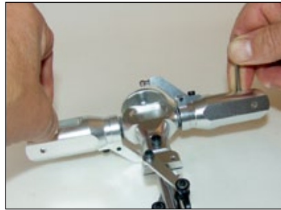
Nach dem fachgerechten Einsetzen der Lager und Scheiben werden die Inbusschrauben festgezogen. Keinesfalls an dieser Stelle Sicherungslack vergessen! Um ein Mitdrehen der Blattlagerwelle zu verhindern, muss mit zwei Inbus-Winkelschlüsseln gearbeitet werden
