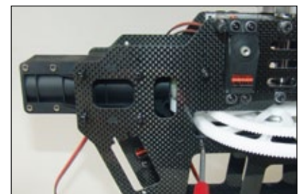
Die gesamte Heckrohraufnahme wird ins Chassis eingesetzt. Die Verschraubung erfolgt wieder mit selbstschneidenden Inbusschrauben (kein Sicherungslack)
