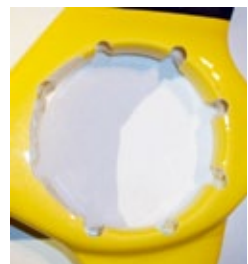
Um den RUSH-Fenestron im Roban-Rumpf einzubauen, müssen Aussparungen gefräst werden
