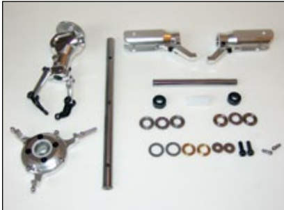
Einzelteile des Ganzmetall-Rotorkopfs. Die Taumelscheibe ist bereits vormontiert
