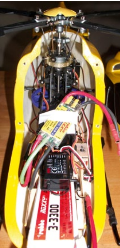
Um das schwere Heck so gut wie möglich auszugleichen, wurden Controller, Flybarless-Empfänger und Flugakku so weit wie möglich vorne platziert. Unter dem Flugakku befindet sich die Batterie zum Betrieb der Beleuchtung
