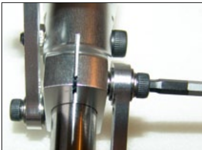
Zwischen Mitnehmerarm und Zentralstück sitzt eine kleine U-Scheibe, damit sich die Kraft beim Anziehen der Schraube über die Kugellager-Innenringe verteilt und der Hebel sich leicht bewegen lässt
