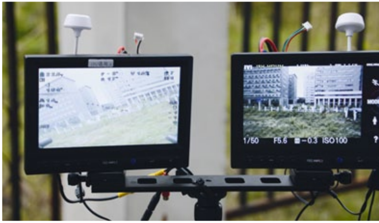
Doppel-Video-Output: Links das Kontrollbild vom S800 mit On-Screen-Info, daneben das Kamerabild mit eingeblendeten Bilddaten. Deutlich zu sehen, dass das Kamerabild unabhängig von der Neigung des Fluggeräts unbeeindruckt bleibt
