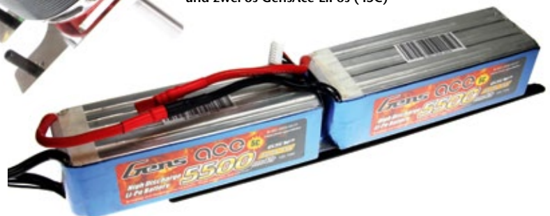
Starke Antriebs-Kombination: Kontronik Kosmik 200, Pyro 800 und zwei 6s GensAce-LiPos (45C)
