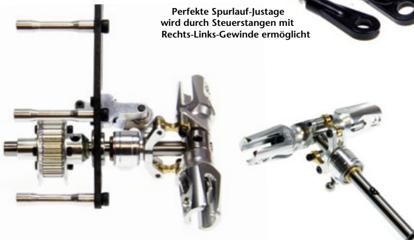
Der edel gefertigte Heckrotor besitzt ein Alu-Zahnriemenrad und eine spielarme Anlenkung
