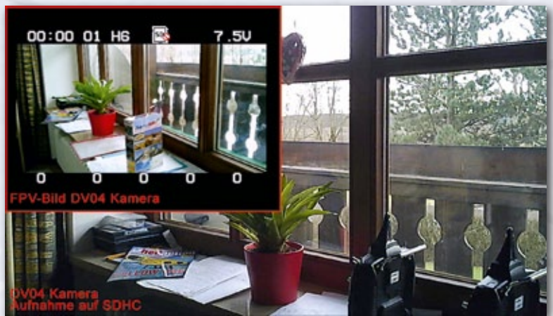
Diese Bildqualität ist maximal zu erwarten. Das FPV-Bild der DV04 hat nur eine geringe Auflösung, die an das Display des Senders angepasst ist. Bei Nutzung einer Brille kommen noch mehr oder weniger kräftige Farbfehler am Bildrand hinzu
