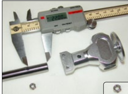
Das Alu-Zentralstück wird mit der 10-mm-Rotorwelle verbunden, wobei eine M4-Inbusschraube mit langem Schaft und Stoppmutter zum Einsatz kommen
