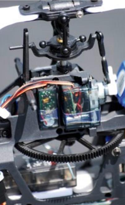
Der Taumelscheiben-Außenring wird mit seinem Stift in einer Führung arretiert. Das verrippte Hauptzahnrad ist fest mit der Rotorwelle verschraubt
