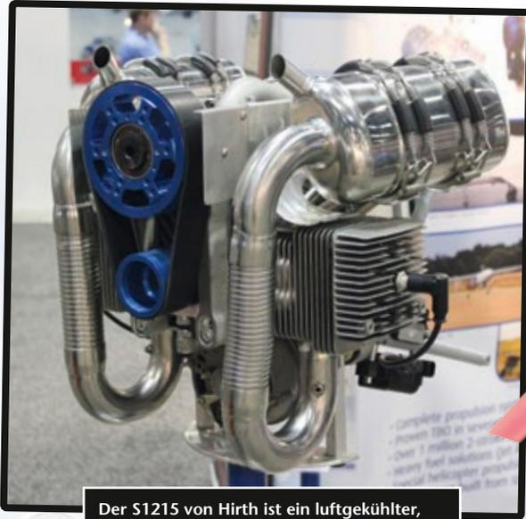
Der S1215 von Hirth ist ein luftgekühlter, membrangesteuerter Zweitaktmotor mit Höhen- und Temperatur-Kompensation. Bei einem Hubraum von 521 Kubikzentimeter leistet das Aggregat 50 PS
