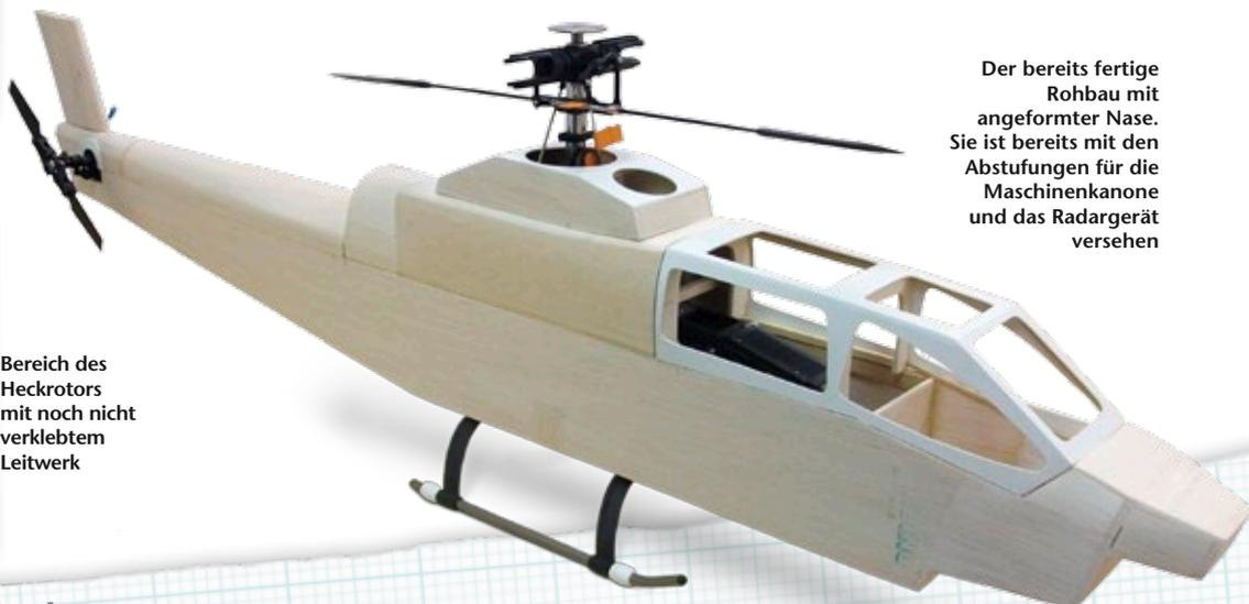
Der bereits fertige Rohbau mit angeformter Nase. Sie ist bereits mit den Abstufungen für die Maschinenkanone und das Radargerät versehen
