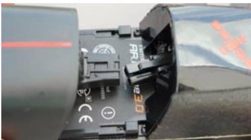
Der 3S-Flugakku hat eine Kapazität von 1.200 Milliampere-stunden und wird mittels Mini-Tamiya-Stecksystem am Kopter angeschlossen. Bei einem Crash werden die Verbindung gelöst und die Stromversorgung getrennt
