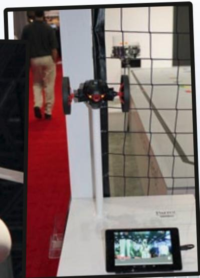
Jumping Sumo lautet der Name dieses Modells von Parrot. Es wird per WLAN gesteuert und gibt ein Live-Bild auf dem Smartphone aus
