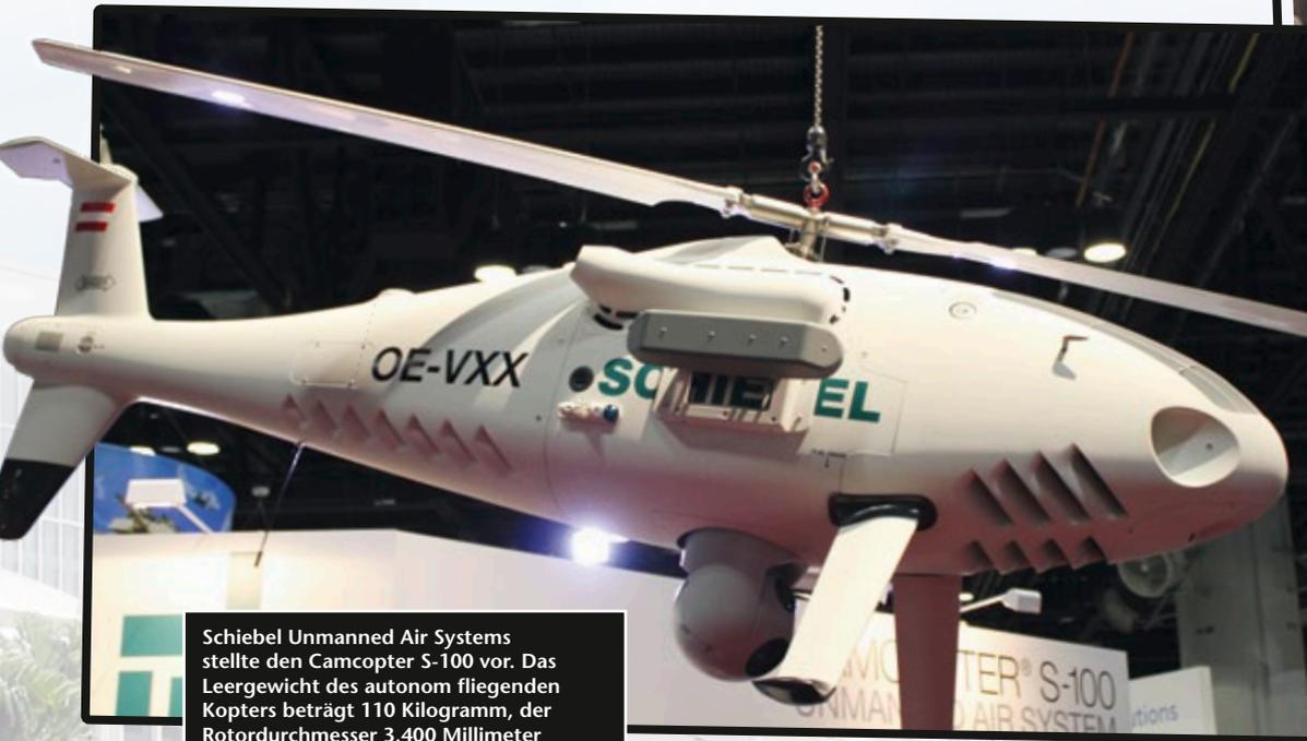
Schiebel Unmanned Air Systems stellte den Camcopter S-100 vor. Das Leergewicht des autonom fliegenden Kopters beträgt 110 Kilogramm, der Rotordurchmesser 3.400 Millimeter
