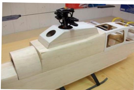
Die Aussparungen der Dom- und Turbinenhaubenteile sind perfekt ans Mechaniksystem angepasst
