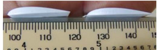
Die Blätter des drehzahlgesteuerten Blade 200 SR X haben ein tragendes Profil (gerade Unterseite)
