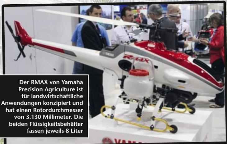
Der RMAX von Yamaha Precision Agriculture ist für landwirtschaftliche Anwendungen konzipiert und hat einen Rotordurchmesser von 3.130 Millimeter. Die beiden Flüssigkeitsbehälter fassen jeweils 8 Liter
