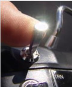
Die Panik-Funktion, die über einen Tastschalter am Sender aktiviert wird, gibt es im Heli-Bereich nur beim Blade 200 SR X. Aktiviert man sie, wird der Heli automatisch in seiner Horizontalen (Funktion Nick und Roll) neutralisiert
