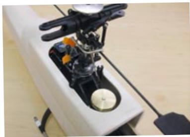
Turbinengehäuse mit halbrundem Turbinenabschluss sowie Öffnungen für die Rotorwelle und Außenläufermotor. Zu erkennen ist auch bereits die Kabinenhaube im Rohbau
