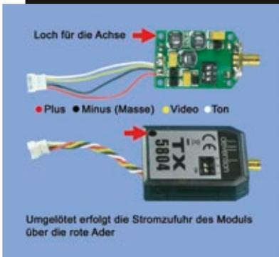
Abbildung 7: Der Umbau des TX5804 ist einfach, muss aber sehr sorgfältig vorgenommen werden
