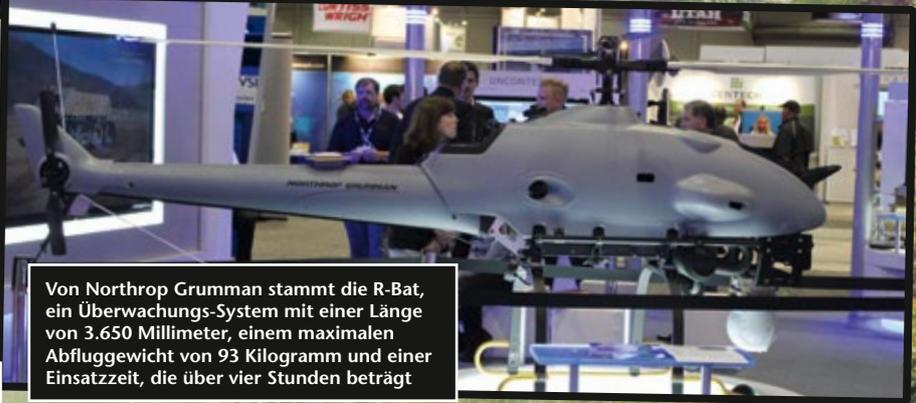
Von Northrop Grumman stammt die R-Bat, ein Überwachungs-System mit einer Länge von 3.650 Millimeter, einem maximalen Abfluggewicht von 93 Kilogramm und einer Einsatzzeit, die über vier Stunden beträgt
