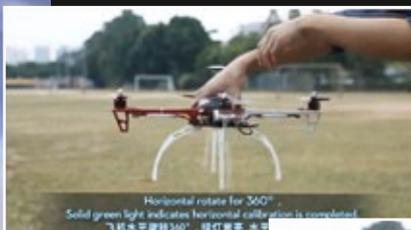
Horizontal rotate for 360°. Solid green light indicates horizontal calibration is completed. 飞机水平旋转360°, 绿灯亮起, 水平校准完成。
