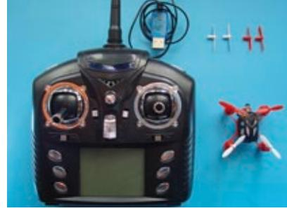
Das alles gehört zum RTF-Set. Der 1s-Flugakku befindet sich auf der Oberseite des Kopters. Geladen wird über USB-Anschluss
