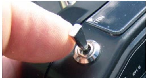
Kanal 5 (kurzer Dreiwegschalter) dient zum Aktivieren der jeweiligen Flugmodi. Schalterstellung 0 ist der Modus für Einsteiger, 1 für Fortgeschrittene und 2 für Experten
