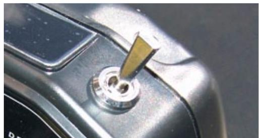
Mit dem rechten oberen Schalter aktiviert man eine zusätzliche Ruderwegverkürzung für Nick und Roll in allen drei Flugmodi. Schalter nach vorn (HI) entspricht nicht reduziertem Ausschlag, Stellung LO reduziertem (Achtung: Im deutschen Manual wurde das vertauscht)
