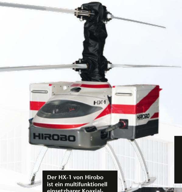
Der HX-1 von Hirobo ist ein multifunktionsell einsetzbarer Koaxial-Heli mit einem 2.400-Millimeter-Rotorkreis einer Länge von 1.253 Millimeter
