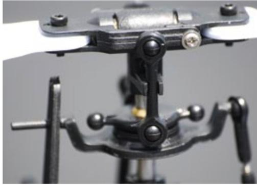
Die Rotorkopf-Wippe ist relativ weich gedämpft. Zur zyklischen Blattverstellung (Nick + Roll) dienen die Doppelkugelgelenke, mit denen die Steuerverbindung hergestellt wird
