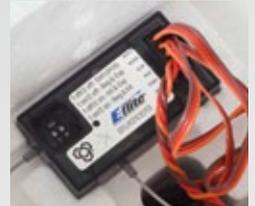
So sieht eine der SAFE-Flächenflug-Versionen aus, fertig eingebaut und abgestimmt. Auch hier sind entsprechende Lagesensoren verbaut
