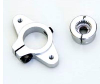
Die Servohebel liegen dem Bausatz bei und sind stufenlos einstellbar. Das eingetragte F steht für Futaba
