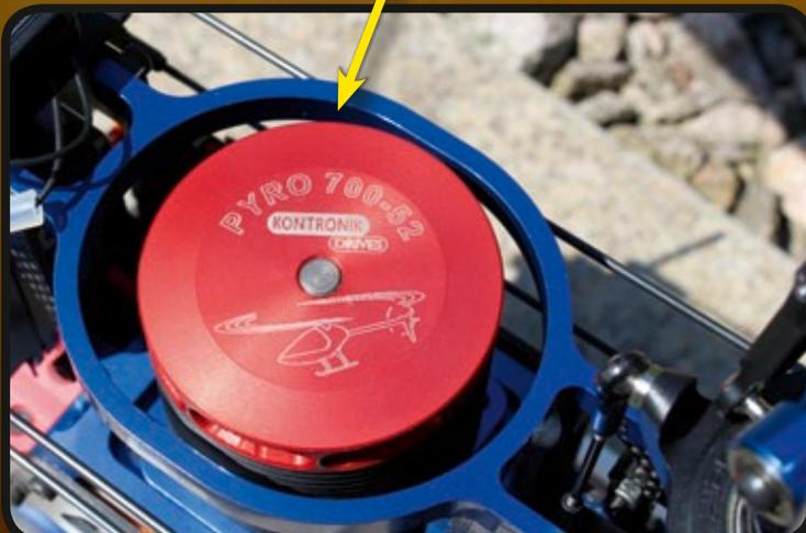
Robuste, aber dennoch sehr leichte Verstreibungen, besonders im Bereich des Antriebsmotors, verleihen dem Chassis enorme Stabilität und Verwindungssteifheit
