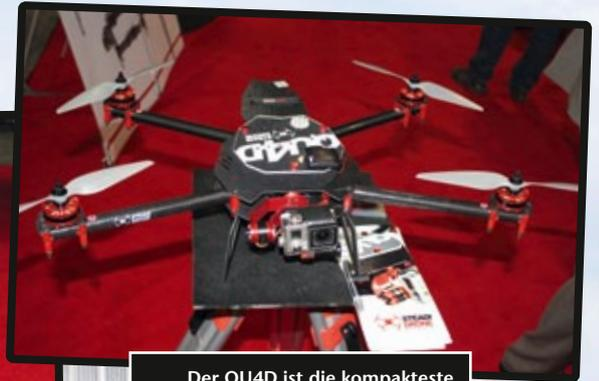
Der QU4D ist die kompakteste Koptergröße im Sortiment von Steadi Drone. Das Modell verfügt über GPS-Navigation und ein integriertes Brushless-Gimbal für Action-Cams des Typs GoPro
