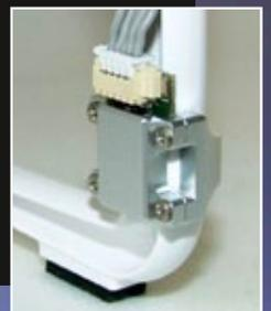
Um ihn und seine korrekte Arbeitsweise geht es – der digitale Magnetkompass, der am Lande-bein aller Phantom-Typen montiert ist. Vor dem Erstflug ist ein Kalibrieren notwendig
