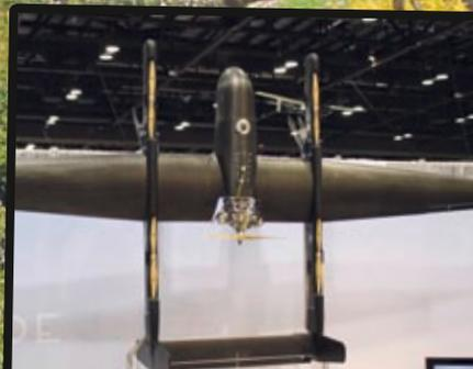
Latitude, bekannt durch sein Hybrid-Quadrotor-Konzept, zeigt mit der HQ50 ein System, das mit Zuladung eine maximale Flugzeit von 24 Stunden erreichen kann
