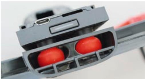
Unter dem Ein-Aus-Schalter sind die roten Dämpfergummis zu sehen, die für ein weiches Aufsetzen des Modells sorgen
