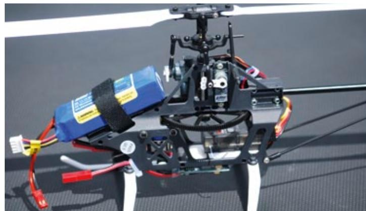
Die beiden Servos für Nick und Roll sitzen direkt unter der Taumelscheibe, der LiPo ist schwerpunktünstig auf der Chassis-Schrägen fixiert
