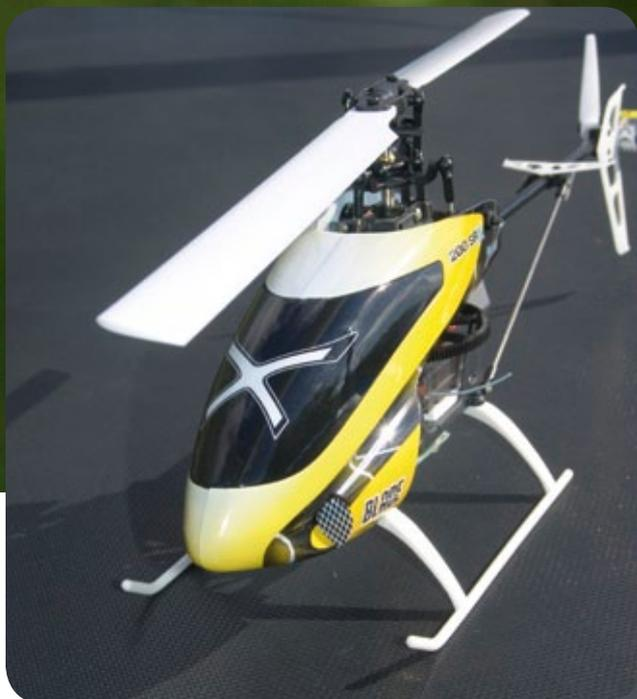
Ganz im Look und Stil der Blade-Serie – der Blade 200 SR X. Markant sind das zweiteilige Kunststoff-Chassis, das drehzahlgesteuerte Hauptrotorsystem und das SAFE-Flybarless-System AR636H
