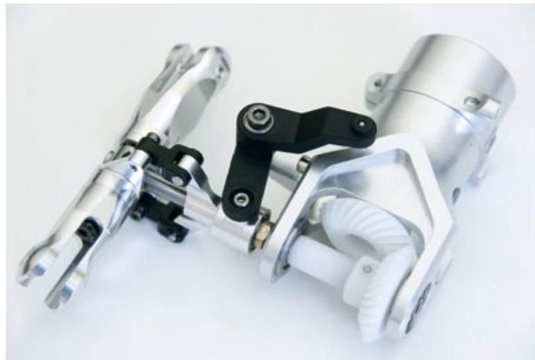
Palloid nennt sich die Art der Schrägverzahnung, die bei den Kegelrädern des Heckrotors zum Einsatz kommt
