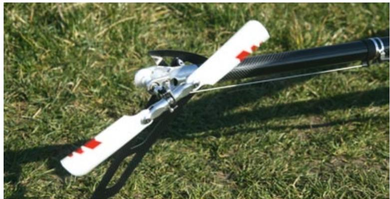
Auch am Heckrotor agieren Blatthalter aus Metall, die mit Radial- und Axiallagern ausgestattet sind. Die spiralverzahnten Kegelräder laufen sehr leise
