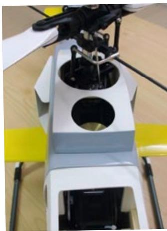
Perfekt angepasste Aussparungen für Taumelscheibe und Motor
