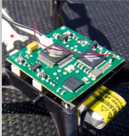
Das kleinste mit SAFE ausgerüstete Modell von Horizon Hobby ist der Quadrokoopter Blade Nano QX. Auch hier ist die komplette SAFE-Flugsteuerung auf einer zentralen Platine untergebracht. Abrufbar sind zwei Flugmodi – Einsteiger und Profi
