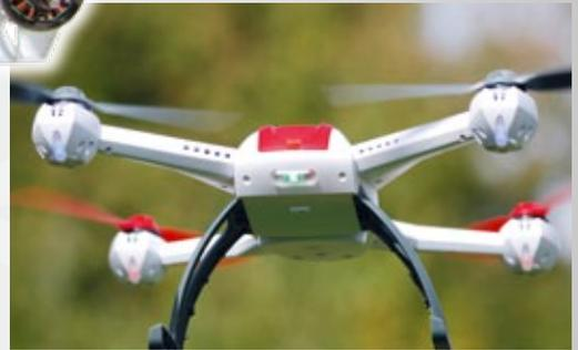
SAFE in höchster Stufe: Besonderes Ausnahme-Talent bei Horizon Hobby in Sachen SAFE – der Quadropters Blade 350 QX. Dank einer ausgeklügelten Elektronik, bestehend aus GPS, Höhensensor und Magnetkompass, kann er autonom punktgenau wie angenagelt schweben
