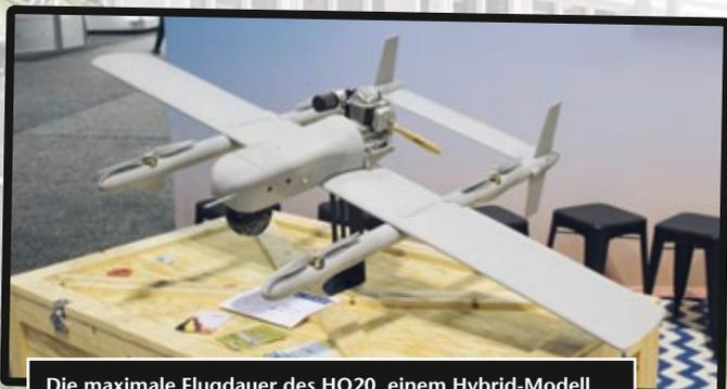
Die maximale Flugdauer des HQ20, einem Hybrid-Modell von Latitude, beträgt fünf Stunden
