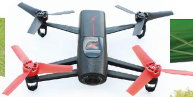
380 Gramm wiegt die Bebop Drone, deren Herzstück die über drei Achsen digital stabilisierte 14-Megapixel-Kamera ist
