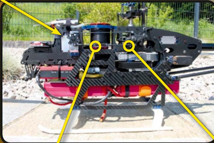
Das Vollcarbon-Chassis bietet ausreichend Platz für alle RC- und Antriebs-Komponenten. Es ist sehr flach aufgebaut, um den Schwerpunkt so nah wie möglich an die Rotorebene zu bekommen. Der Antriebsakku wird auf einer Carbon-Rutsche befestigt, die von hinten ins Chassis geschoben und mittels Schnellverschluss arretiert wird
