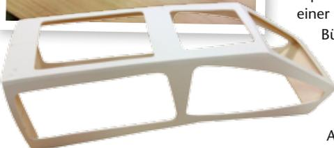
Kabinenhaube im Rohbau mit Spanten und Seitenteilen (oben) Unten hier die rohbaufertige Version
