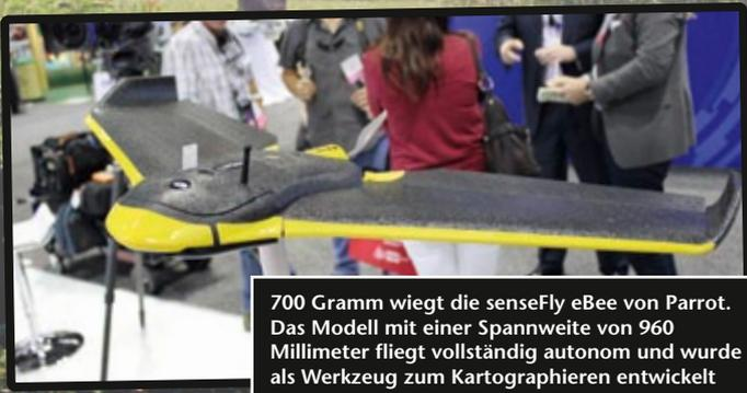
700 Gramm wiegt die senseFly eBee von Parrot. Das Modell mit einer Spannweite von 960 Millimeter fliegt vollständig autonom und wurde als Werkzeug zum Kartographieren entwickelt
