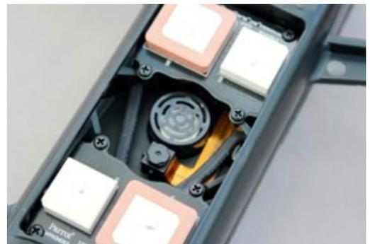
Auf der Unterseite des Modells befinden sich vier WLAN-MIMO-Keramikantennen, jeweils zwei mit 2,4- und 5-Gigahertz sowie die vertikale Stabilisierungskamera, die im 16 Millisekunden-Takt den Untergrund abtastet, um die Geschwindigkeit zu ermitteln
