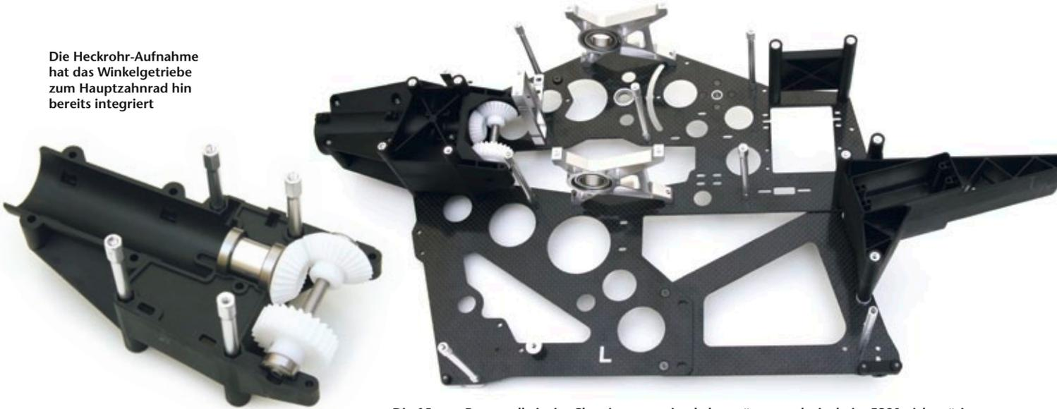
Die 15-mm-Rotorwelle ist im Chassis nur zweimal abgestützt – mehr ist beim E820 nicht nötig
