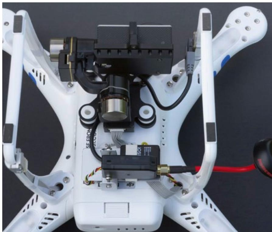
Abbildung 4: Fertiger Aufbau. Das CAN-Bus-Kabel verläuft zwischen den Trägerplatten des Gimbal. Das achtpolige graue Kabel muss frei beweglich bleiben
