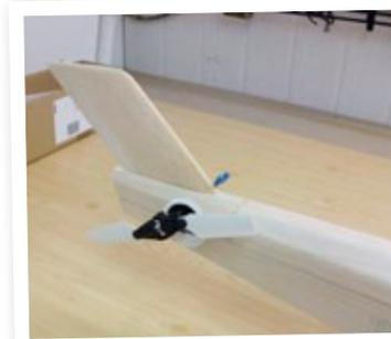
Bereich des Heckrotors mit noch nicht verklebtem Leitwerk
