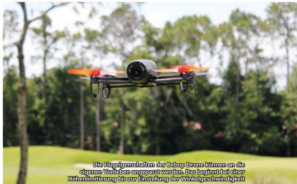
Die Flugeigenschaften der Bebop Drone können an die eigenen Vorlieben angepasst werden. Das beginnt bei einer Höhenlimitierung bis zur Einstellung der Winkelgeschwindigkeit
