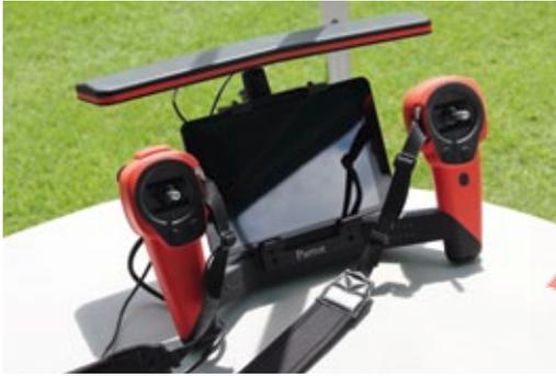
Der Prototyp des Sky-Controllers: Die vier integrierten Antennen sollen die WLAN-Reichweite auf bis zu 2.000 Meter vergrößern
