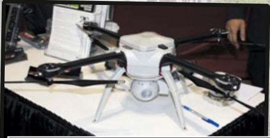
50 Minuten Flugzeit verspricht der Sky Ranger von Aeryon Labs. Die Ausleger lassen sich schnell abnehmen, was den Kopter sehr transportfreundlich macht. Der Sky Ranger soll selbst bei Windgeschwindigkeiten von 90 Kilometer pro Stunde einsetzbar sein
