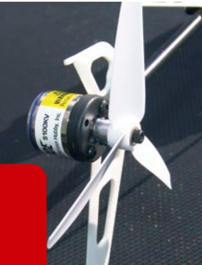
Am Ende des Alu-Heckrohrs (Durchmesser 5 mm) befindet sich der Brushless-Heckmotor, der formschlüssig in einer Kunststoff-Aufnahme eingebettet ist. Während des Betriebs wird der Antrieb gerade mal nur handwarm
