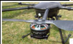
Kraftvolle Außenläufermotoren in Verbindung mit CFK-Props sorgen für entsprechende Leistung
