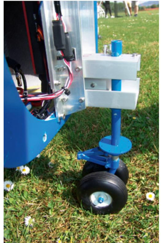
So ist die Bugrad-Aufhängung mit der Mechanik verschraubt
