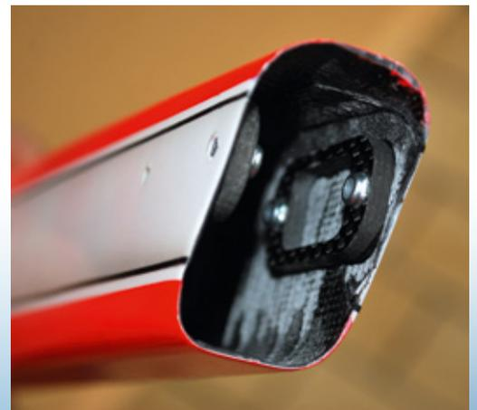
Die Befestigungen des Heckrotors im Heckausleger wurden mit UHU Plus Endfest 300 eingeklebt
