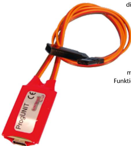
Die Ausgänge der ProgUnit: zum Controller (→ Leitung mit JR-Flachsteckhülse), zum Empfänger (→ Leitung mit JR-Flachsteckbuchse) und zum PC (Mini-USB auf USB)
