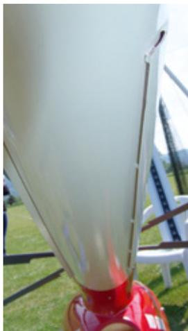
Blick von unten auf den Heckausleger. Rechts befindet sich in Längsrichtung eine Luft-Auslassdüse zur Entlastung des aufzubringenden Gegendrehmoments. Links befindet sich eine Strömungs-Abrisskante
