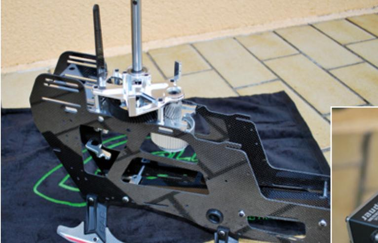
Die Getriebe-Einheit wird ins Chassis eingesetzt und mit acht M3-Schrauben befestigt
