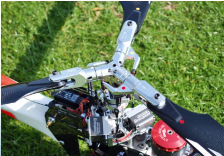
Der Rotorkopf mit montierten Blättern. Durch das Loch am Blatthalter wird der Blattverstellarm verschraubt
