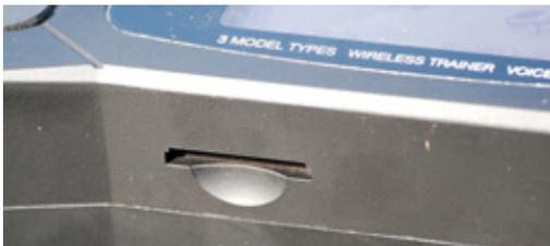
Der SD-Kartenslot ist bequem von außen zugänglich. Mit der SD-Karte kann der Speicher erweitert, aber auch Modellsicherungen und Updates durchgeführt werden
