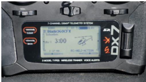
Zwei Taster und ein Rolldrucktaster (rechts) dienen zum Navigieren durchs Menü. Das Display ist hintergrundbeleuchtet und auch bei Sonnenlicht bestens ablesbar
