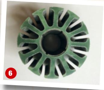
6 Isolation des Stators mit Deckscheibe
