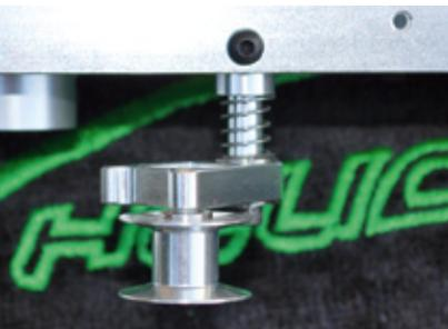
Der Spanner für den Heckrotor-Antriebsriemen ist aus Alu gefertigt und am Getriebeblock verschraubt
