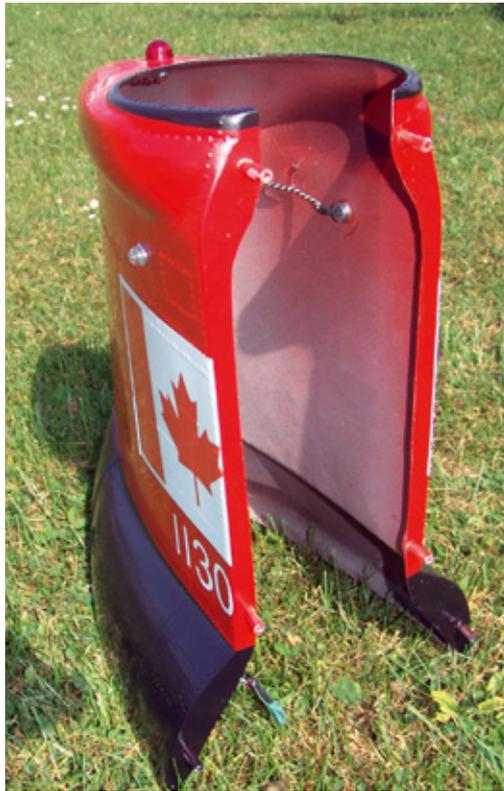
... das Hauben-Heckteil sind abnehmbar gestaltet. Die Arretierung erfolgt mit Hilfe von Dübeln und Magneten
