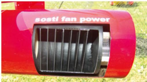
Die komplette Endkappe kann gedreht werden, was eine Umlenkung des Luftstroms bewirkt und zur gewünschten Hochachsensteuerung führt. Das Heckservo sitzt innerhalb der Kappe ganz hinten (Alu-Rippen des Servogehäuses sind erkennbar)
