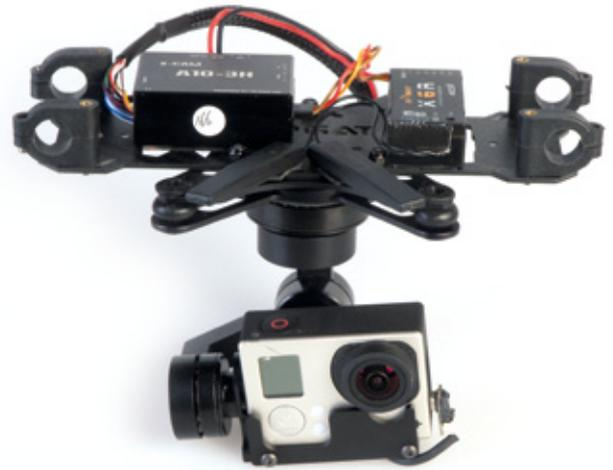
Die Erprobung des Dreiachs-Gimbals erfolgte unter anderem im DJI-Multikopter S800EVO, wo die Einheit dank der passenden Befestigungsschellen sehr einfach montiert werden kann
