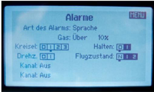
Das Menü „Alarmer“, bei dem auch Sprachansage zugeordnet werden kann
