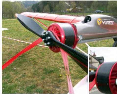
Yuneeec entwickelt und produziert nicht nur Multikopter, sondern ist auch in der bemannten Luftfahrt mit der Herstellung von eigenen, elektrisch angetriebenen Flugzeugen aktiv. Hier der luftfahrtzugelassene E-Spyder mit seinem 24-Kilowatt-Motor
