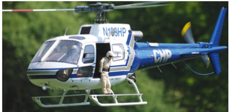
Die Ecureuil AS 350 B3 von Francis Paduwat aus Belgien. Das 22 Kilogramm schwere Modell mit 2,36-Meter-Dreiblattrotor wird von einem Kontronik Pyro 850 angetrieben, wobei 12s-LiPos mit 10.000 Milliamperestunden zum Einsatz kommen
