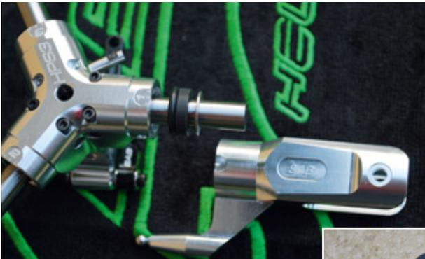
Auf die Dämpfungsbuchse wird der O-Ring aufgesetzt, alles gut gefettet und dann ins Zentralstück geschoben. Anschließend werden die Passscheibe mit 1 Millimeter (mm) und in der Regel eine zweite mit 0,2 mm eingesetzt
