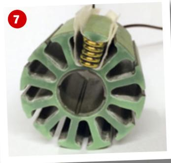
7 Der Wickelprozess startet mit dem sogenannten 1. Zahn der 1. Gruppe. Verwendet wird hier ein 1,7 Millimeter starker Draht
