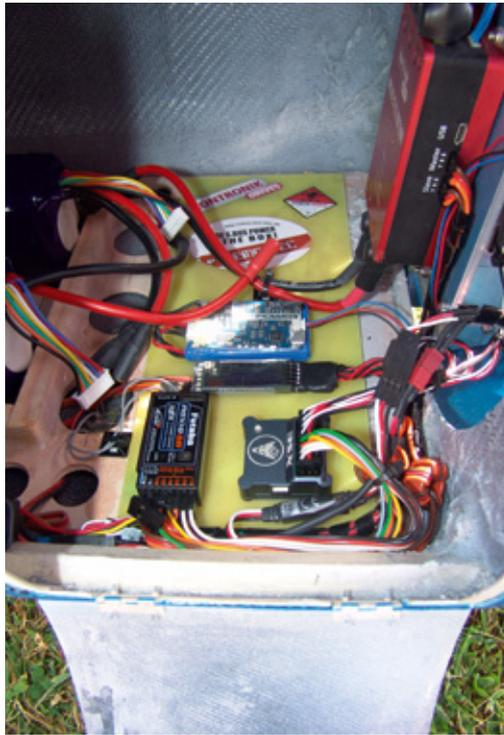
Die RC-Platte, auf der Empfänger, Beleuchtungselektronik, Pufferakku sowie das bavarianDEMON SX untergebracht sind
