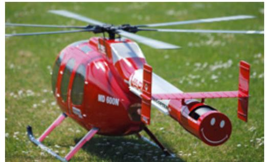
Prototyp, der zeitnah bei Vario Helicopter in Serie gehen wird: die mit Sechsstab und Notar-System ausgerüstete MD 600N von Stefan Reusch. Über das große Gitter am Dom wird Luft für den oberen Fan angesaugt
