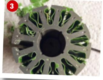
3 Die Serien-Isolation eines Stators wird abgepellt
