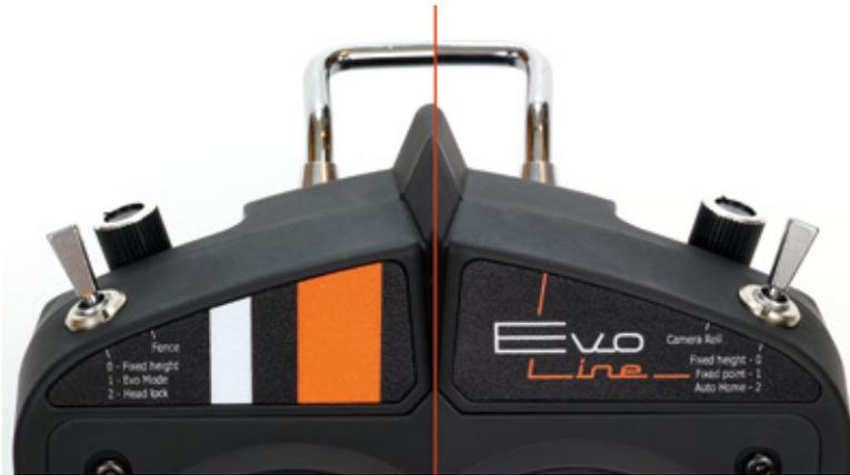
Die an der Stirnseite angeordneten Schalter und Drehregler für die Flugmodi. Unten im Bild der geöffnete Sender
