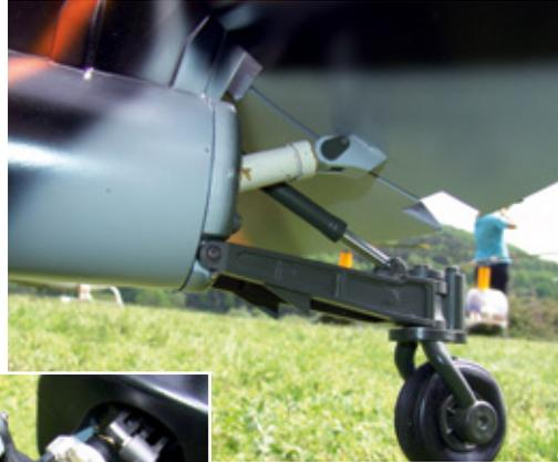
So sieht die Aufhängung des Spornfahrwerks sowie die Anlenkung des Höhenruders aus
