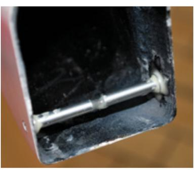
... und an diesen Aluteilen abgestützt. Damit beim Demontieren diese Gewindeteile nicht immer eingefädelt werden müssen, wurden sie ebenfalls verklebt
