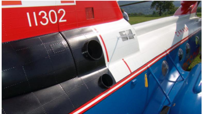
Die Nieten-Anformungen sind bereits in der aufwendig von Helifischers erstellten Negativform berücksichtigt. Das unterstreicht in Verbindung mit Klappen, Öffnungen und Gittern den entsprechenden Scale-Charakter des Modells
