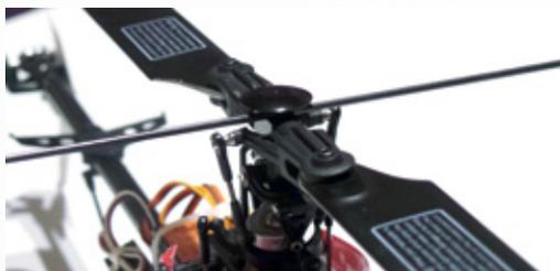
Die im Text erwähnte Stange, die am Rotorkopt-Zentralstück unter dem Bremssteller als Hilfsebene zum Justieren des Einstellwinkels fixiert wurde
