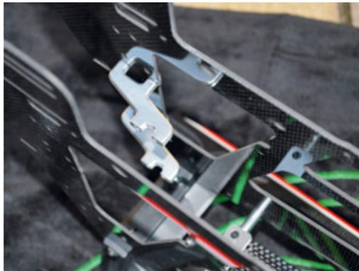
Die Befestigung für das Heckrotorservo. Es wird nicht wie bei den anderen Gobblins üblich im Heckausleger verschraubt, sondern sitzt im Hauptchassis
