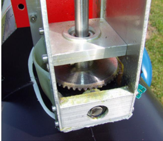
Der Rotorwellenantrieb erfolgt über ein stabiles Stahl-Kegelradgetriebe
