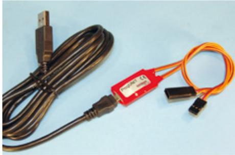
Die ProgUnit kommt mit einem USB-Anschlusskabel und zweisprachiger Bedienungsanleitung
