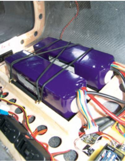
Links von der RC-Einbauplate werden die beiden 6s-LiPos verstaut. Ein Rahmen sowie Gummiringe sorgen dafür, dass nichts verrutscht
