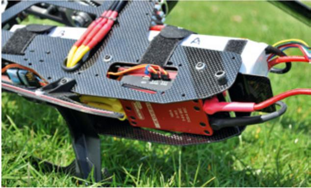
Der Kosmik ist im unteren Chassis verschraubt. Dahinter befindet sich der Jlog 2.5
