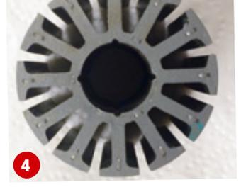
4 Die Pulverbeschichtung des Stators ist entfernt
