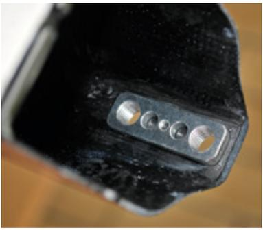
An diesem Aluteil wird der Heckausleger mit dem Vorderteil verschraubt ...
