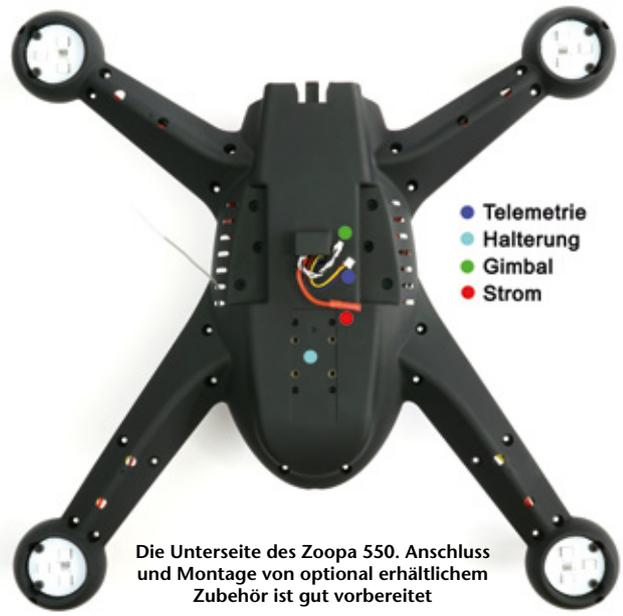
Die Unterseite des Zoopa 550. Anschluss und Montage von optional erhältlichem Zubehör ist gut vorbereitet
