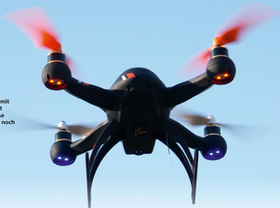
trug mit nicht serienmäßigem 3.300er nVision-30C-LiPo bei 0 oder 300 Gramm Zuladung etwa 12 beziehungsweise 15 Minuten, im Normalbetrieb mit Sicherheitsreserve realistisch sind eher zwei bis drei Minuten weniger. Am Ende leitet der Kopter eine automatische Landung ein, die man zur Schonung des LiPos und der Nerven allerdings vermeiden sollte. Ins Akkufach passen LiPos bis etwa 140x35x28 mm, bei flacher Bauform bis 140x45x23 mm. Ein LiPo mit über 4.000 mAh ist als Zubehör geplant.
