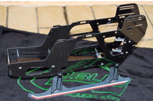
Das Carbon-Chassis mit Kufenlandegestell. Die Kanten der Kohlefaser-Seitenteile wurden entgratet
