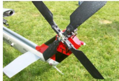
Ein Vario-Heckgetriebe nebst Vierblatt ergänzen die Heckpartie. Dem aufmerksamen Leser wird auffallen: Eines der vier Heckblätter ist falsch herum montiert, was versehentlich in der Eile beim Aufbau passiert ist
