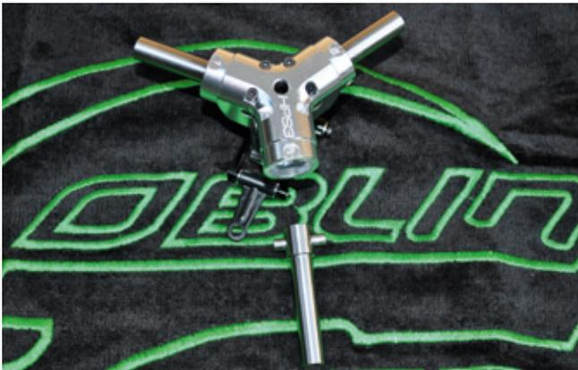
Die aus dem Zentralstück des Rotorkopfs demontierte Blattlagerwelle hat einen Querstift, der mit zwei M2,5-Schrauben fixiert ist
