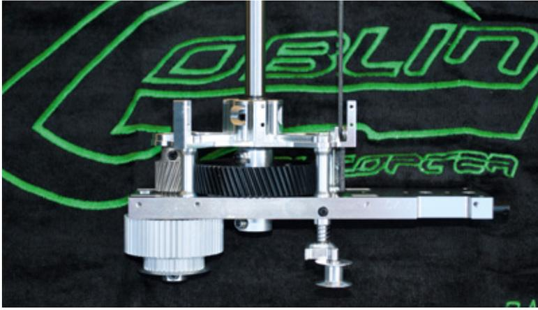
Das ist alles sehr hochwertig gefertigt und passt perfekt – das Hauptgetriebe des Urukay
