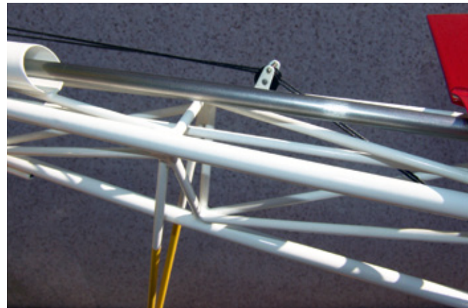
Hier die unmittelbar vor dem Heckrotor sitzende Seilzug-Umlenkrolle
