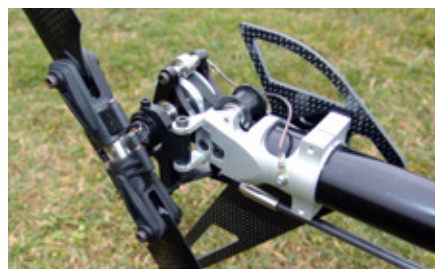
Der Heckrotor ist präzise und spielfrei. Die Anti-Statik-Leitung von Riemenrolle zu Heckrohr wurde vom Autor in Eigenregie angebracht
