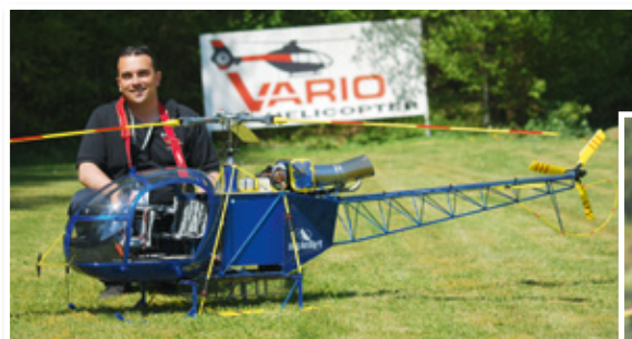
Nicolas Aubert vom VARIO Team Frankreich führte seine im Maßstab 1:4 ausgeführte VARIO Lama SA 315 im „Sud Aviation“-Outfit vor. Daten: Rotordurchmesser 2.500 Millimeter, Abfluggewicht 19 Kilogramm und Antrieb über eine Jakadofsky-Turbine des Typs Pro 5000
