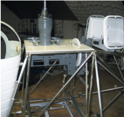
Rohbaustadium: Die Mechanik mit Domplatte
