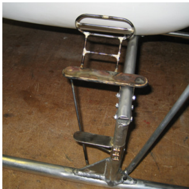
Die Einstiegshilfen beziehungsweise Trittstufen an den vorderen Kufenbügeln bestehen aus Edelstahlblech und Edelstahlrohr sowie aus Silberstahl mit 2- und 3-mm-Durchmesser
