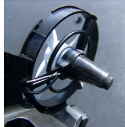
Die fest am Chassis angeformten Motorenaufnahmen dienen auch als Landebeine
