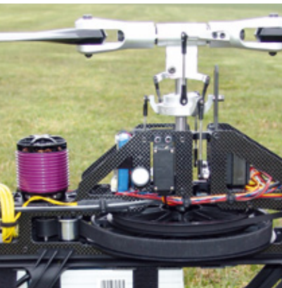
Die Führungsrolle im Zugtrum des Riemens sorgt für einen besonders großen Umschlingungswinkel des Motor-Riemenrads
