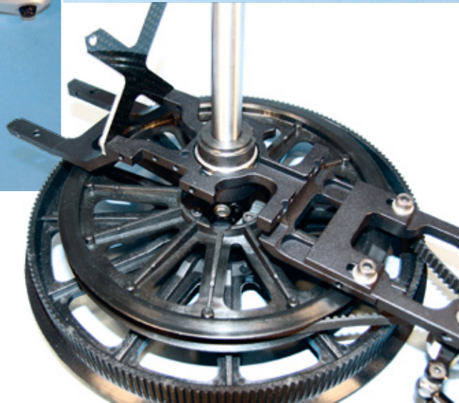
Ein Drucklager unter der mittleren Hauptrotorwellen-Aufnahme sorgt für leichten Lauf unter axialer Last
