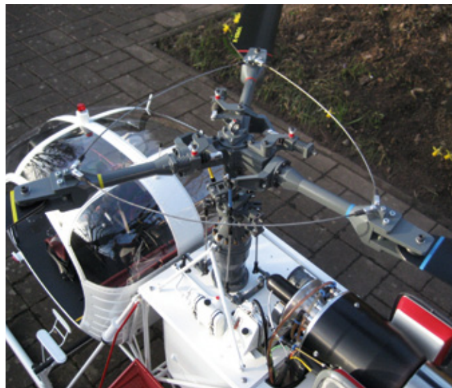
Der vorbildgetreue Dreiblatt-Hauptrotor von XXL-Modellhelicopter
