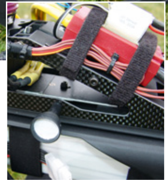
Der Kapazitäts-Sensor des VBar Control sitzt huckepack auf dem JIVE Pro. Das ergibt kurze Leitungslängen
