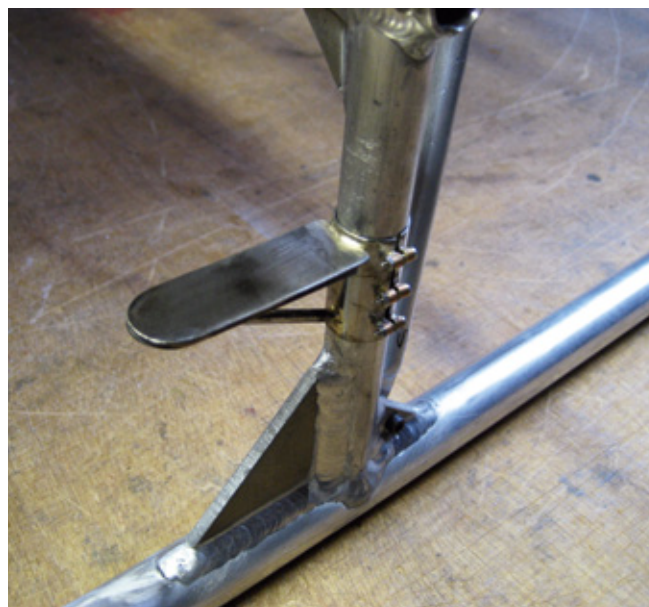
Die Einstiegshilfen beziehungsweise Trittstufen an den vorderen Kufenbügeln bestehen aus Edelstahlblech und Edelstahlrohr sowie aus Silberstahl mit 2- und 3-mm-Durchmesser
