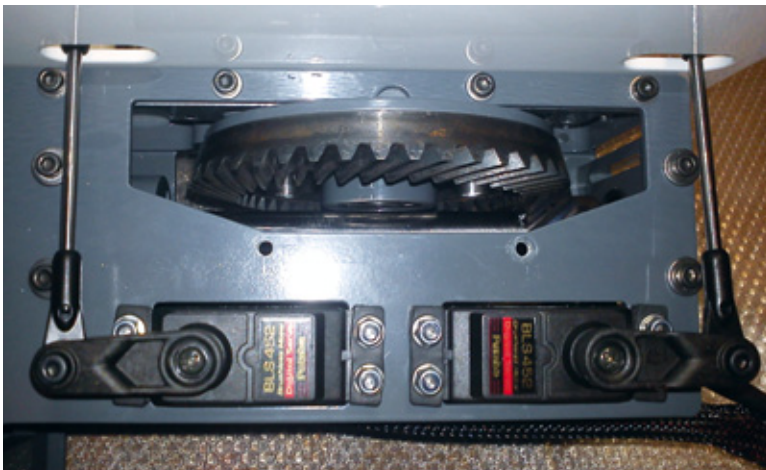
Zwei von insgesamt vier in der Mechanik sitzenden Taumelscheibenservos Futaba BLS 432
