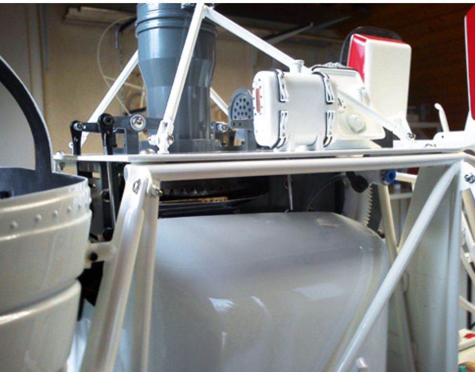
In der Seitenansicht wird die Verschraubung des Ölbehälters deutlich, darunter die Tankverkleidung
