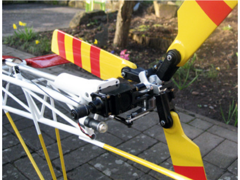
Die eigentliche Heckanlenkung erfolgt präzise über ein Gestänge und 90-Grad-Umlenkhebel. Der Dreiblatt-Heckrotor passt perfekt zum gesamten Outfit der Lama
