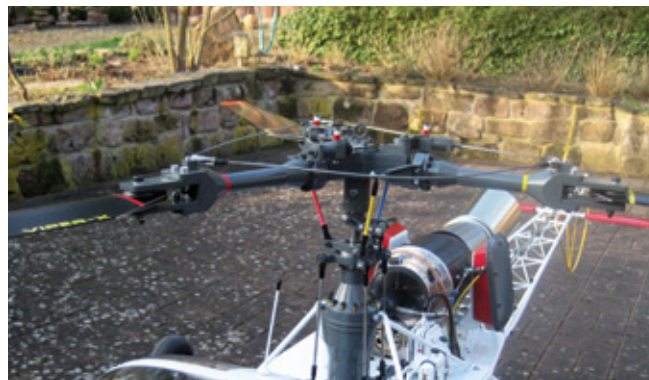
Die in den vorbildgetreuen Blatthaltern eingesetzten Viper X-Hauptrotorblätter von CAD-Modelltechnik Jung haben eine Länge von 1.050 Millimeter und passen sehr gut zum gesamten Rotorkopf-Outfit
