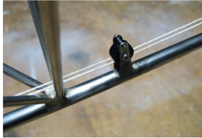
Detail einer am Ausleger befestigten Seilzug-Umlenkrolle, die nur als Attrappe dient
