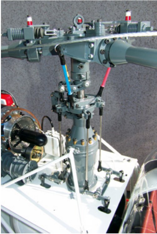
Hier die gesamte Rotormast-Einheit mit abgestrebtem Alu-Dom und Vierpunkt-Anlenkung
