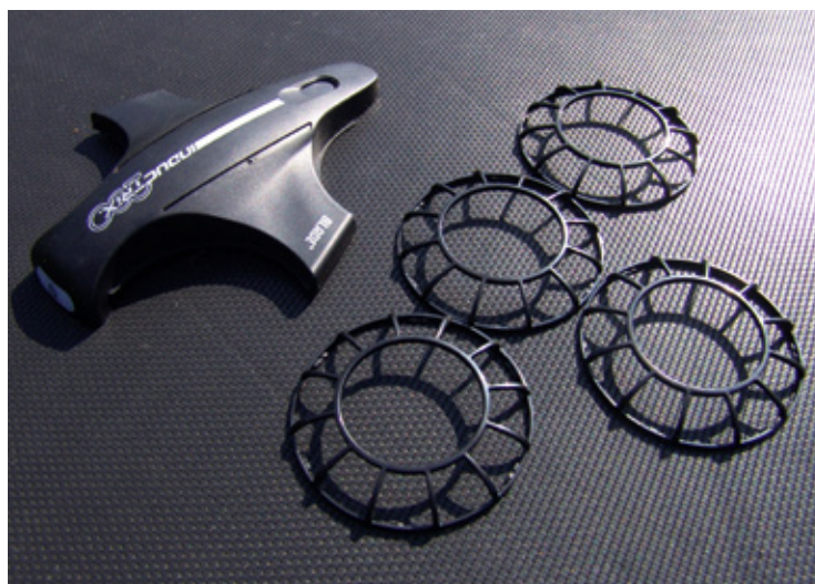
Durch Lösen von drei Schrauben lässt sich die Haube demontieren, nachdem zuvor die Propschutzringe entfernt wurden
