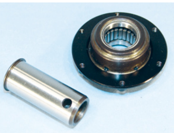
Der Freilauf ist ein massiver Klemmkörperfreilauf, der wie die gehärtete Hülse im Gehäuse von zwei Kugellagern geführt wird
