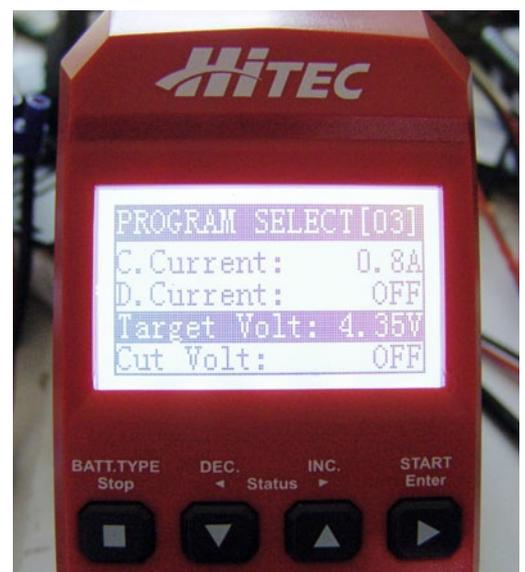
Mit dem HiTEC X1 RED kann man auch sogenannte Hochvolt-LiPos handhaben, die auf eine maximale Zellenspannung von 4,35 Volt (Menüpunkt „Target Volt“) aufgeladen werden können
