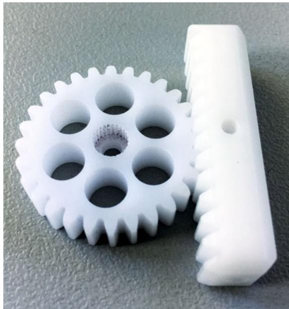
Der Zahnrad/Zahnstangen-Antrieb des Linear-Drive-Systems. Deutlich zu erkennen ist der im Zahnrad eingearbeitete Vielzahn, der auf dem entsprechenden Gegenstück des Servo-Abtriebszahnrad montiert wird
