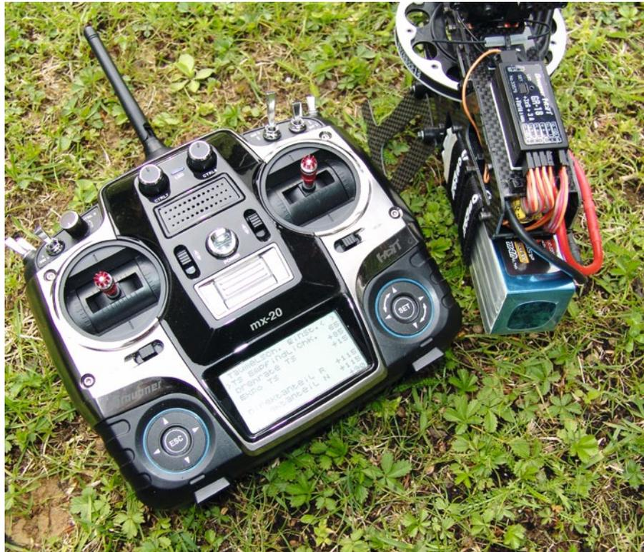
Die Parameter des Graupner Flybarless-Systems sind komfortabel per Telemetrie im Sender einstellbar
