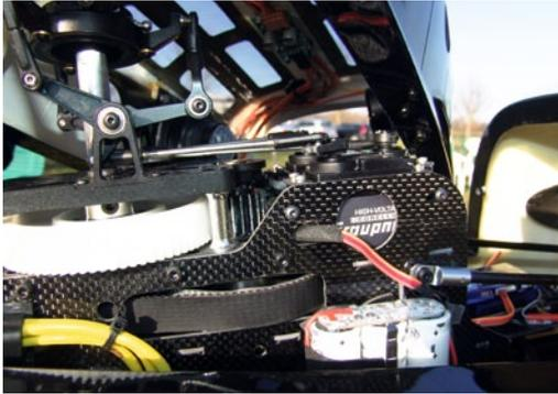
Roban-Standard: Hinter der Rotorwelle sitzen die drei Taumelscheiben-Servos, die über die an der Domplatte befestigten Umlenkhebel den Taumelscheiben-Außenring anlenken
