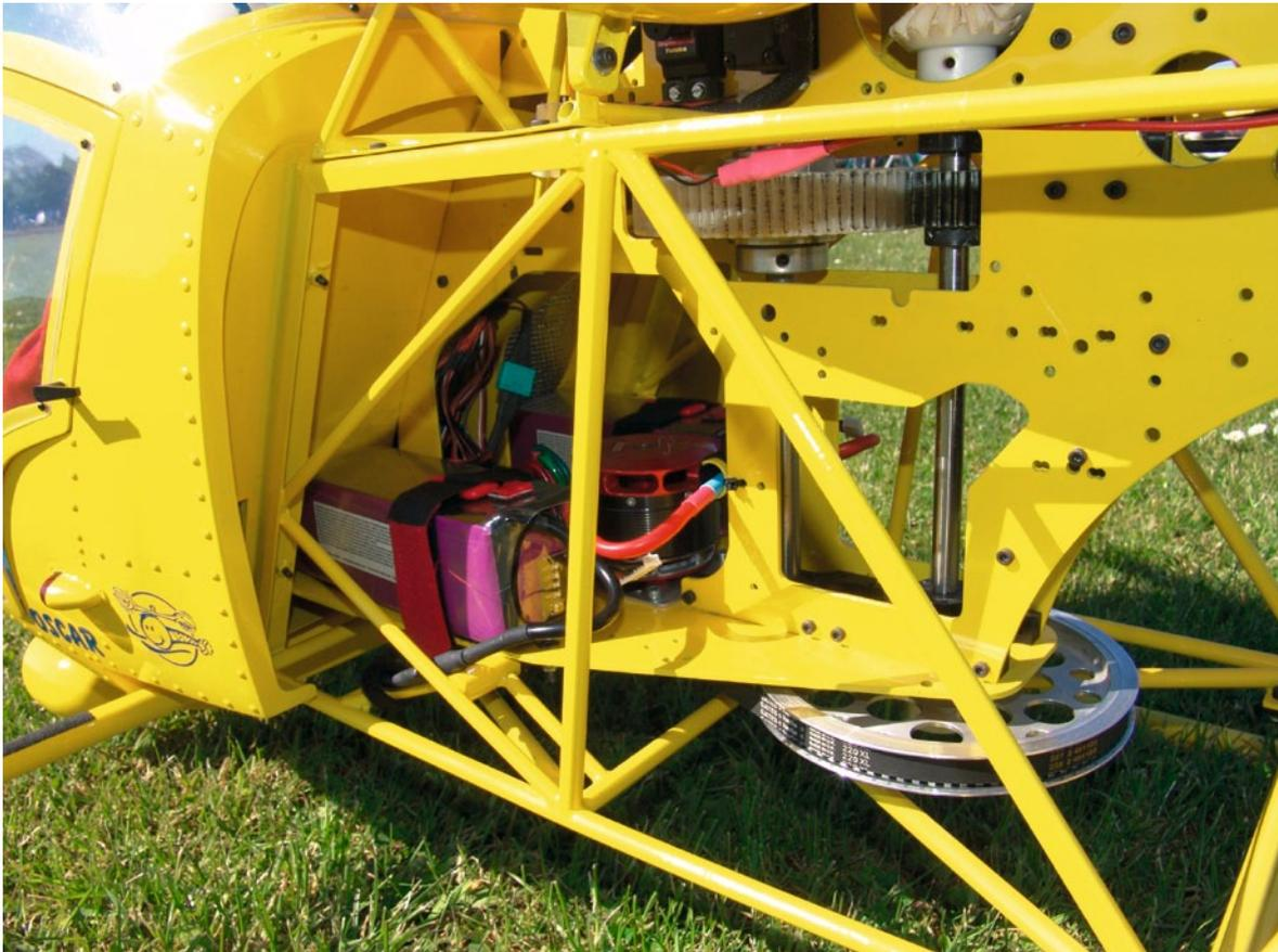
Das Getriebe der „Benzin“-Mechanik (siehe Text) ist zweistufig ausgelegt. In der ersten arbeitet ein Zahnriemen (ganz unten), von wo aus über eine lange Ritzelwelle die zweite Stufe (Zahnradgetriebe) angetrieben wird
