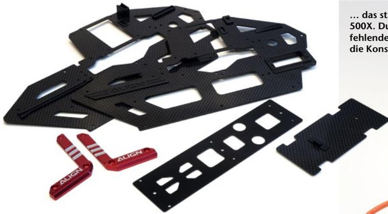
... das stabile Chassis des T-Rex 500X. Durch die hier noch fehlende linke Seitenplatte wird die Konstruktion verdeutlicht
