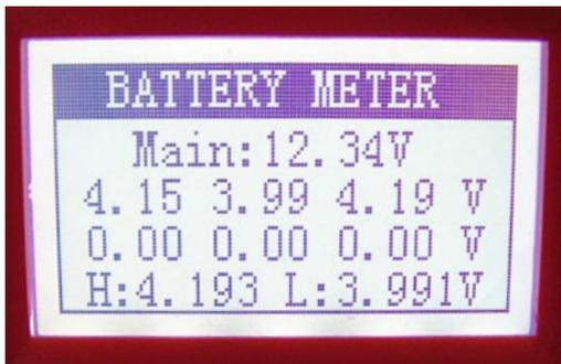
Mit dem Battery-Meter kann man sich Einzelzellen-Spannungen innerhalb eines Packs anzeigen lassen, aber ...
