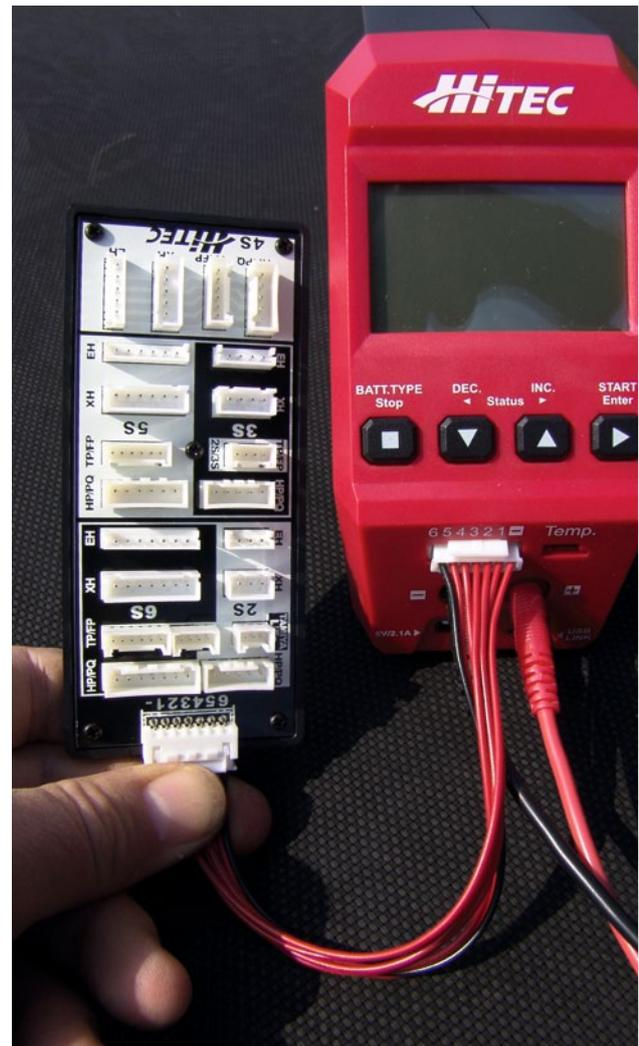
Das Balancerboard (bis 6s) nebst Anschlusskabel gehört mit zum Lieferumfang
