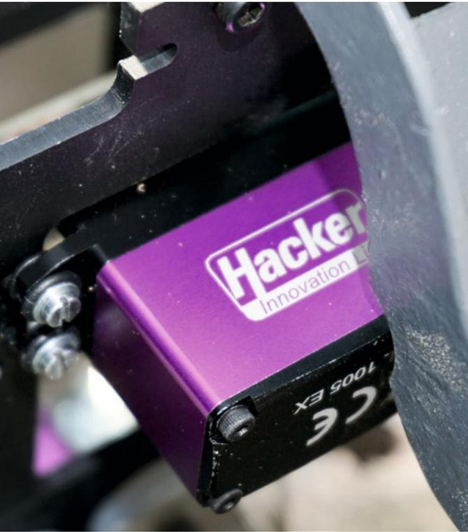
Für die Heckrotor-Ansteuerung ist ein DITEX TD1005S in der Mechanik eingebaut
