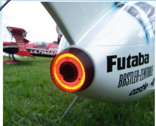
Angetrieben wird Björns Hughes 500 zwar elektrisch, doch der entsprechende LED-Leuchtring im Turbinen-Auslass sorgt für einen realistischen „Afterburner“-Effekt, der auch bei grellestem Sonnenschein bestens zu erkennen ist
