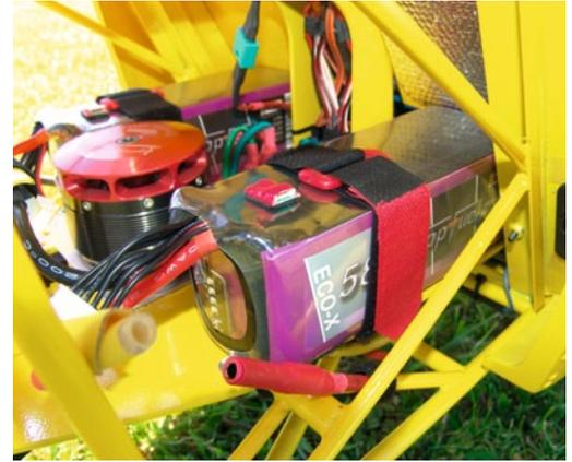
Der Pyro ist auf der Chassis-Bodenplatte montiert, die beiden in Serie geschalteten 6s-LiPos von Hacker flankieren ihn beidseitig
