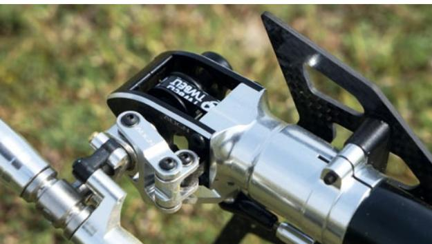
Spielarm und robust – der über Zahnriemen angetriebene Heckrotor des 500X
