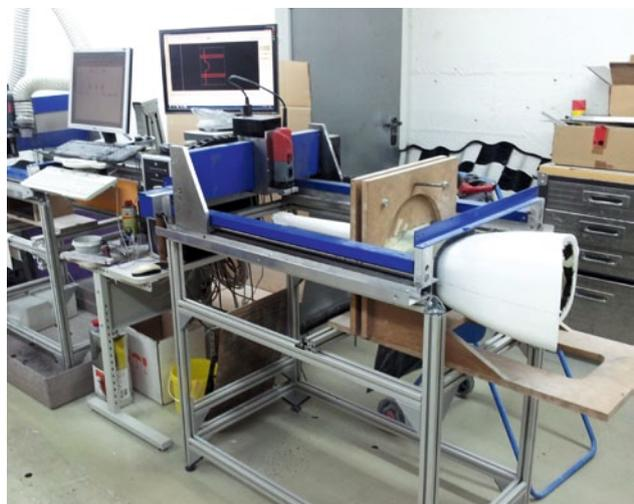
Stabile Seitenlage für die Hughes 500, damit nachher auch alles passt. Hier im Fräsraum werden gerade die Langlöcher für die Aufnahme des Heckrotor-Getriebegehäuses ausgefräst
