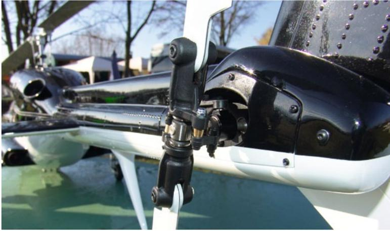
Der Heckrotor mit seinem Kegelrad-Getriebe ist formschlüssig verkleidet. Man beachte die zahlreichen Nieten-Immitationen, die serienmäßig am gesamten Rumpf angebracht sind
