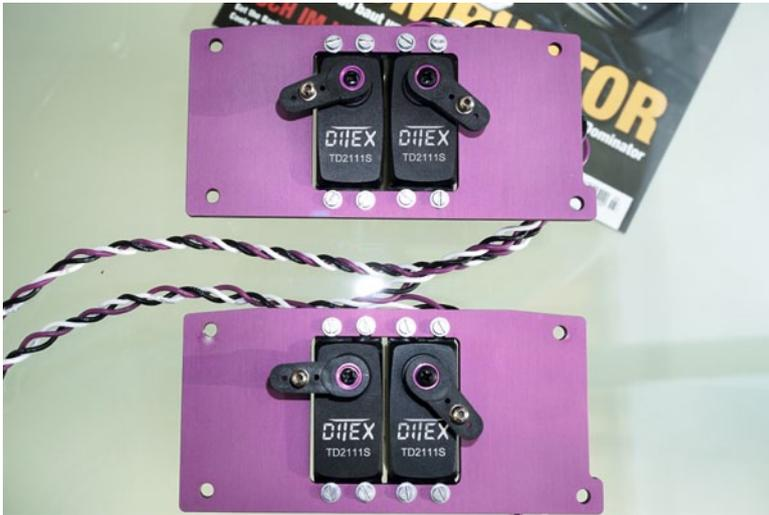
Bei den DITEX ist keine Demontage der Hebel nötig, wenn die Servo-Mittelstellung nicht erreicht wird. Das lässt sich bequem ...
