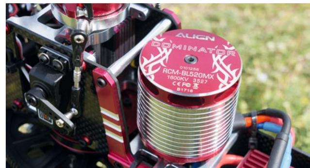
Im Bereich des Motors werden die Seitenteile von Alu-Winkeln flankiert
