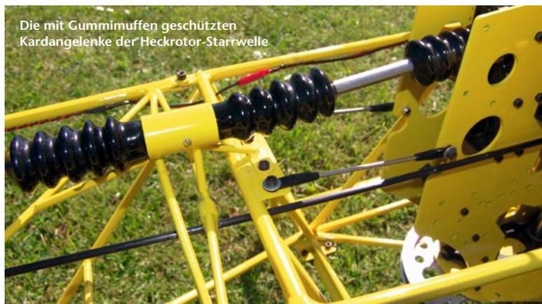
Die mit Gummimuffen geschützten Kardangelenke der Heckrotor-Starrwelle
