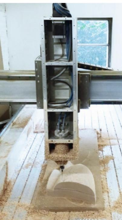
Selbstverständlich werden beim Heli-Center-Berlin auch alle Urmodelle angefertigt, mit deren Hilfe später die Positivformen erstellt werden. Hier ist gerade ein Fräser bei der Arbeit
