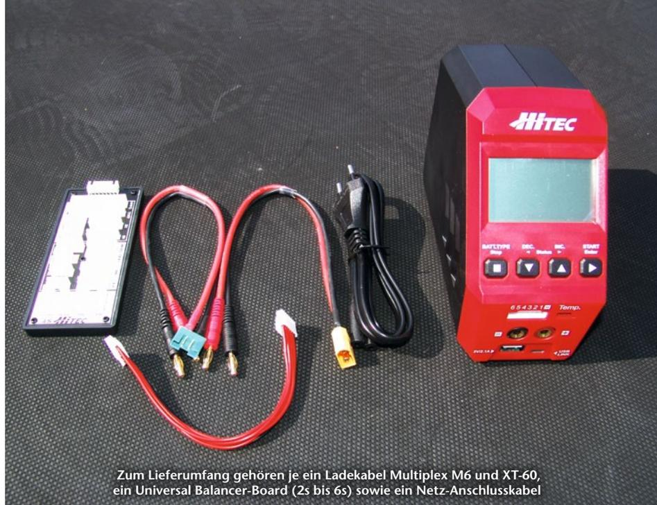
Zum Lieferumfang gehören je ein Ladekabel Multiplex M6 und XT-60, ein Universal Balancer-Board (2s bis 6s) sowie ein Netz-Anschlusskabel
