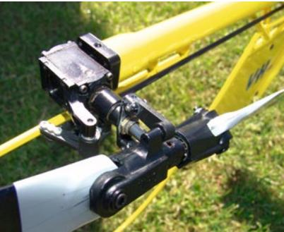
Der Vario-Heckrotor wird über eine Kohlefaser-Schubstange angelenkt, die ...
