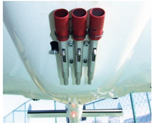
Der am Rumpfbau montierte Raketenwerfer von Vario, der ...
