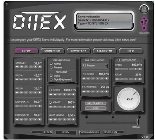
... via DITEX-Manager-Software unter „Setup“/ „Mittelstellung“ realisieren, nachdem das Servo über USB mit dem entsprechenden Computer verbunden ist (siehe Status-Anzeige oben rechts)
