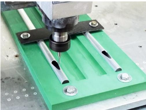
Maßarbeit: Hier werden in den Kufenrohren passgenaue Einfürungen vorgenommen, um später die Kufenbügel aufnehmen zu können
