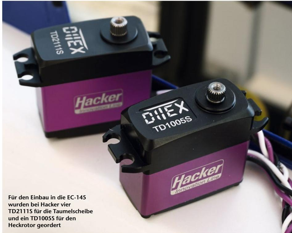
Für den Einbau in die EC-145 wurden bei Hacker vier TD2111S für die Taumelscheibe und ein TD1005S für den Heckrotor geordert
