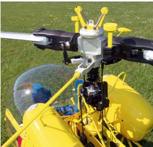
An der Paddelwippe sind Umlenkhebel (keine Bell/Hiller-Hebel) montiert, die lediglich zur Ruderweg-Verkürzung dienen
