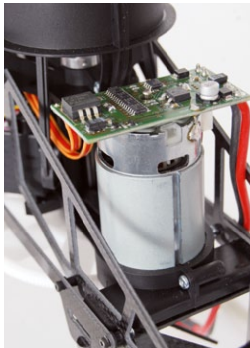
Direkt am hinteren Lagerschild des Hauptmotors ist die Controllerplatine angelötet
