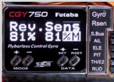
Sensor-Test. Dieser Wert sollte über 60 Prozent liegen
