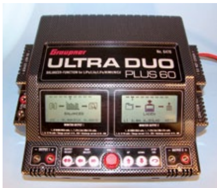
Die Bedienkomponenten auf einen Blick. Zentrales Element ist der in der Mitte angeordnete Knopf, mit dem alle neun Haupt-Menüpunkte angefahren und mit einem kurzen Druck gestartet werden können
