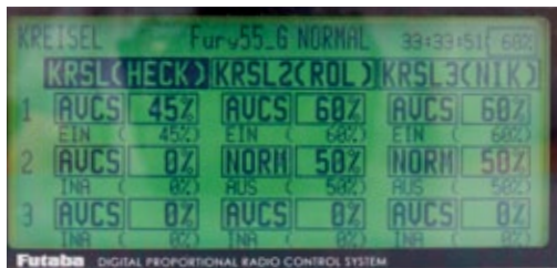
Das komfortable Einstellmenü der Fernsteuerung ermöglicht die direkte Vergabe der Empfindlichkeit für die einzelnen Achsen
