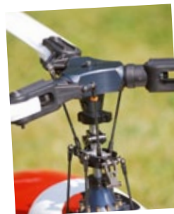
Raffiniert gelöst – der Dom mit anmontierter Taumelscheibenführung
