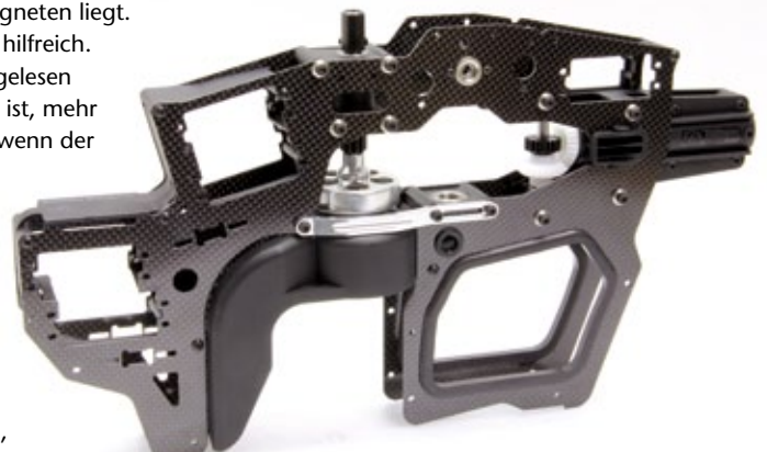
Das weitestgehend fertig montierte Chassis im Rohzustand. Man beachte die Alu-Versteifung unterhalb der Kupplungseinheit
