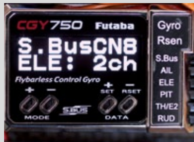
S-Bus-Signalkonfiguration. Es können die Signale der Fernsteuerung gemappt werden
