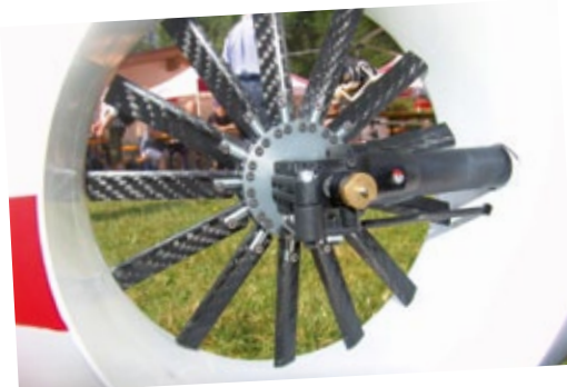
Der 13-blättrige Fenestron der Gazelle arbeitet zwar jetzt schon einwandfrei, entspricht jedoch noch nicht dem Serienstand. In Kürze werden zusätzliche Statoren die Heck-Performance nochmals steigern
