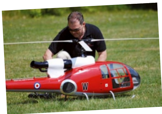
Dave Hollins bei den Startvorbereitungen. Deutlich zu erkennen ist der an der rechten Rumpfsseitenwand befindliche Turbinenauslass
