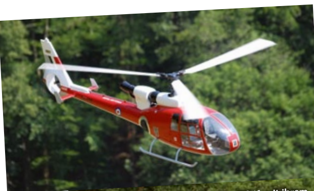
Die für Turbine ausgelegte Gazelle SA341 mit ihrem markanten Fenestron Heck hat durch ihre schlanke Rumpfgeometrie ein schnittiges Flugbild
