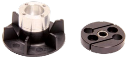
Das Gebläsead sitzt auf einer großen Alu-Nabe (Schwungradeneffekt). Der Stahl-Kupplungsläufer ist mit einem Freilauflager ausgestattet
