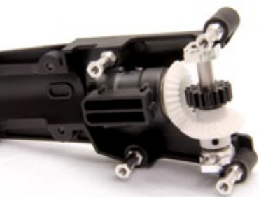
Markant beim X50 Torque Tube ist der Heckrotor-Starrantrieb. Hier das entsprechende Getriebe mit den robusten Kegelrädern
