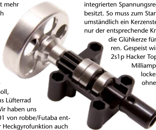
Die mit gewichtmindernden Aussparungen versehene Alu-Glocke ist dreifach gelagert. Der Sechskant-Starteradapter ist bereits montiert
