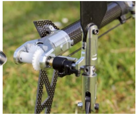
Der superleichte und robuste Heckrotor des TT. Die Blatthalter sind jeweils mit Drucklagern ausgestattet. Pitchbrücke, Schiebehülse und Umlenkhebel sind aus Kunststoff
