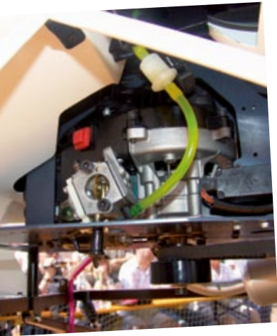
Blick auf den im Chassis montierten Benzinmotor G230. Deutlich zu erkennen ist die unter der Bodenplatte befindliche erste Getriebestufe (Zahnriemen) inklusive Fliehkraftkupplung
