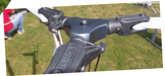
Der linksdrehende Dreiblatt-Hauptrotor mit Metall-Zentralstück und massiven Kunststoff-Blatthaltern
