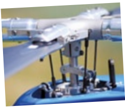
Der Vierblattrotor von Heli-Factory in Ganzmetall-Ausführung. Der Rotordurchmesser beträgt 2.300 Millimeter, die bevorzugte Drehzahl 930 Umdrehungen pro Minute
