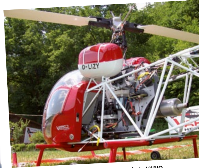
Zum Antrieb dient die im Gitterrahmen integrierte VARIO-Benzinmechanik mit frontseitig angeordnetem Motor
