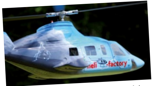
Die Bell 430 von Heli-Factory basiert ebenfalls auf einem Rumpfbausatz der Firma VARIO. Hier arbeitet eine XL-Elektromechanik mit einem Motor Hacker A80/8 und Jeti Master Spin-Controller. In Verbindung mit einem 12s LiPo-Akkus mit 10.000 Milliamperestunden sind mit dem etwa 14 Kilogramm schweren Modell Flugzeiten von bis zu 15 Minuten möglich
