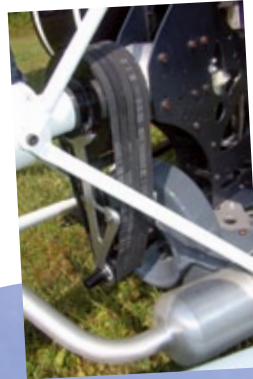
Beim bemannten Vorbild agieren hier an dieser Stelle Keilriemen zur Kraftübertragung von Motor zu Getriebe – hier beim Modell mit Zahnriemen imittiert
