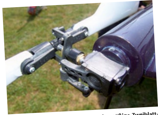
Der serienmäßige Zweiblatt-Heckrotor mit Kunststoff-Blatthaltern
