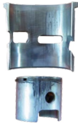
Verschleißbild eines Ringkolbens nebst Buchse
