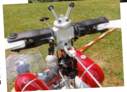
Der Zweiblatt-Hauptrotor mit der untenliegenden Stabilisierungsstange, die – wie beim bemannten Vorbild – keine Paddel hat, sondern an der Gewichte montiert sind
