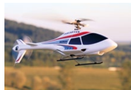
Für den Rundflug wird eine zweite Flugphase programmiert, in der etwas Nick nach vorne getrimmt wird
