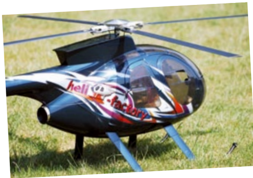
Die Turbinenversion mit vorbildgetreu angeordnetem Auslass
