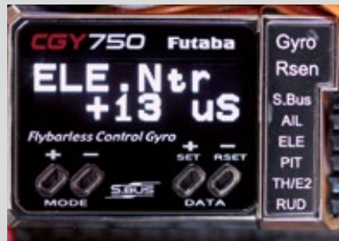
Konfigurieren der Servonullstellung
