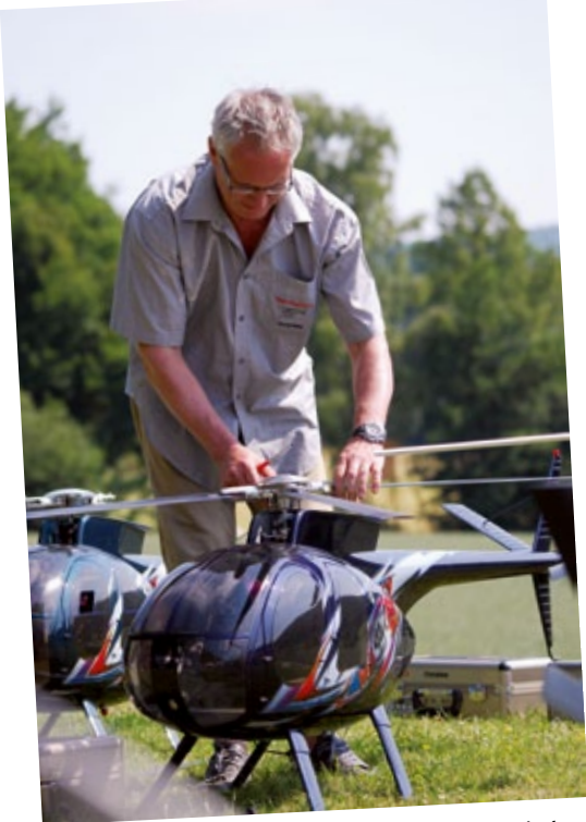
Georg Maier von der Firma Heli-Factory demonstrierte eindrucksvoll mit zwei identisch lackierten Hughes 500 C den Stand der Technik. Links in der Maschine arbeitet eine Turbine JetCat PHT3L (offenes Fenster ist für Frischluftzufuhr), in der gerade in Vorbereitung befindlichen Hughes agiert ein Elektroantrieb
