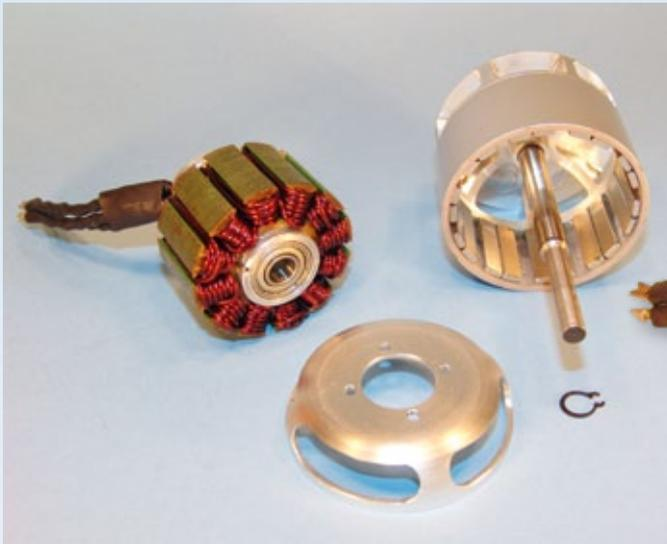
Die Motorwelle ist von 8 mm innen auf 6 mm für das Ritzel außen abgesetzt und mit einem Sicherungsring fixiert. Der große Wellendurchmesser stabilisiert die Rotorglocke im Lauf
