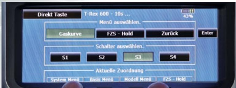
Die Schnellwahltasten unterhalb des Displays lassen sich modellspezifisch mit beliebigen Funktionen belegen. Dazu als erstes die gewünschte Funktion aufrufen (beispielsweise Gaskurve) und im zweiten Schritt S1 und S4 gleichzeitig drücken. Es erscheint ein Auswahlmeneü zum einfachen Verknüpfen der Funktion
