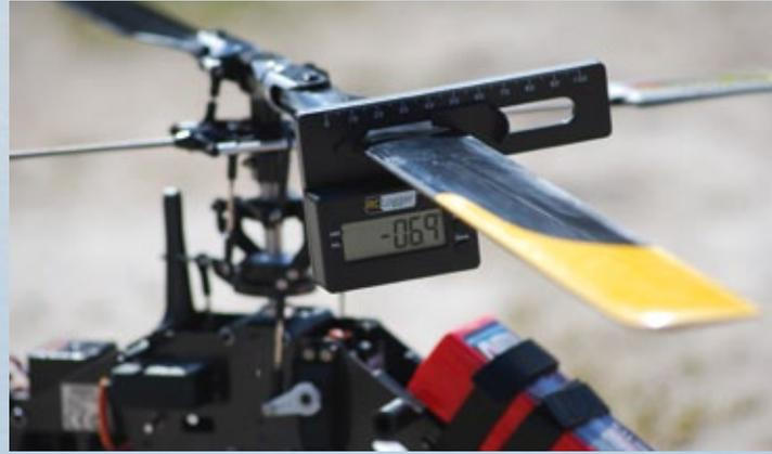
Die vom Werk eingestellten Pitchwerte in Verbindung mit dem Originalsender sind für Einsteiger und Fortgeschrittene Piloten gut gewählt
