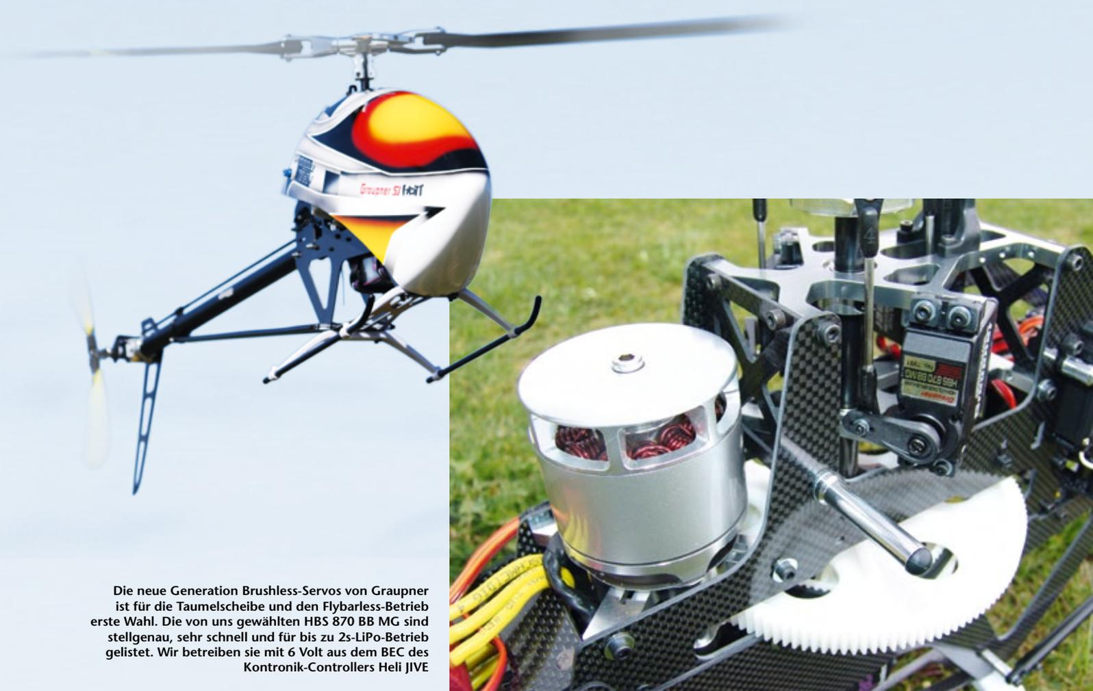
Die neue Generation Brushless-Servos von Graupner ist für die Taumelscheibe und den Flybarless-Betrieb erste Wahl. Die von uns gewählten HBS 870 BB MG sind stelligenau, sehr schnell und für bis zu 2s-LiPo-Betrieb gelistet. Wir betreiben sie mit 6 Volt aus dem BEC des Kontronik-Controllers Heli JIVE
