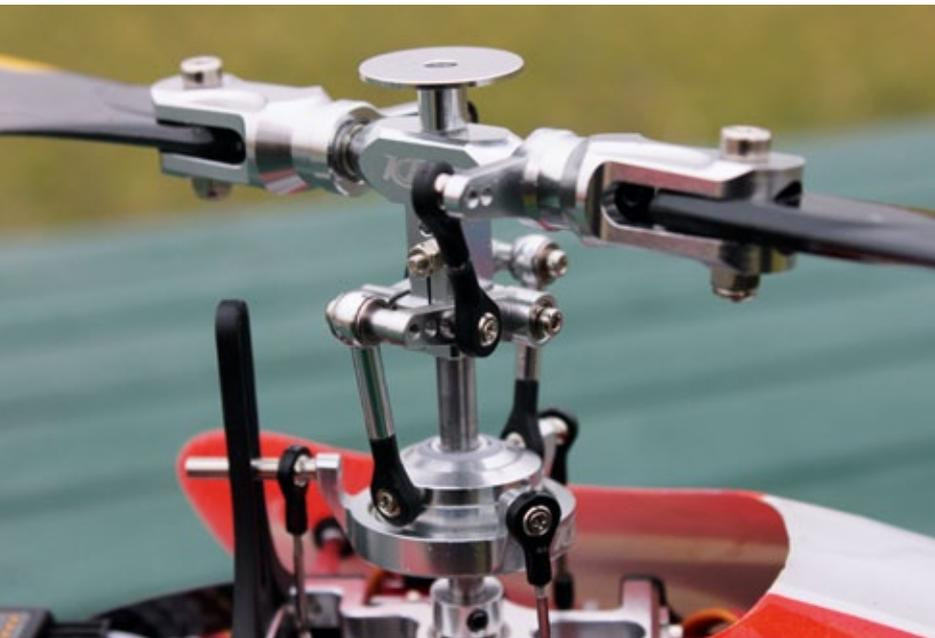
Clevere Lösung am robusten Ganzmetall-Hauptrotorsystem. Blattanlenkung und Taumelscheiben-Mitnehmer liegen auf einer Ebene. Die zusätzlich vorhandenen Gewindebohrungen bieten zusätzliche Möglichkeiten, die Agilität des Modells zu beeinflussen
