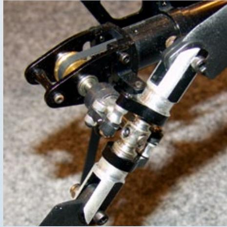
Der Heckrotor ist spielarm ausgeführt, wird über Zahnriemen angetrieben und hat robuste Blatthalter aus Aluminium. Auch die Gehäuse-Seitenteile sowie das Zahnriemenrad sind in Metall ausgeführt
