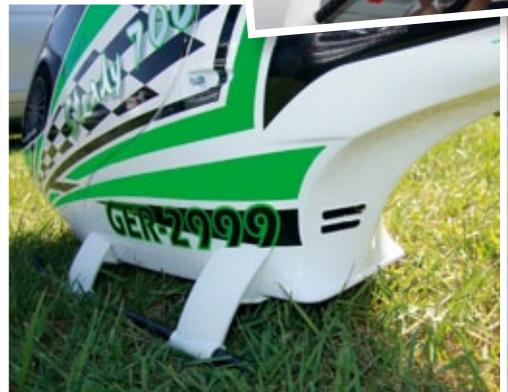
In den Versteifungs-Ausformungen beim Übergang zum Heckausleger befinden sich Luft-Austrittslöcher
