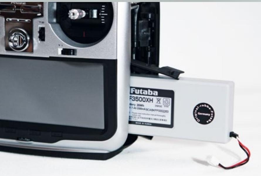
Unter dem rechten Griffteil befinden sich Akku, USB-Anschluss und ein SD-Cardslot für unbegrenzte Modellspeicher. Der mini-USB-Port dient nur für Servicezwecke
