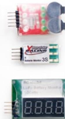
Mehrzellige LiPos müssen mit dem Balancer-Anschluss (weißer Stecker) geladen werden
