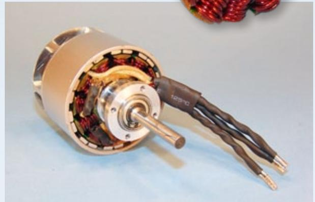
Die Pole im Rotor werden durch jeweils zwei Magnetstäbe gebildet, um besser dem Radius des Statorschnitts folgen zu können (Luftspalt)
