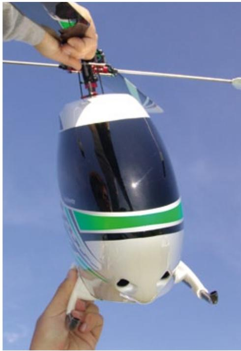
In der Frontansicht sind die beiden Luft-Eintrittsöffnungen in der Nase erkennbar, die Frischluftzufuhr für Akkus, Controller und Motor gewährleisten
