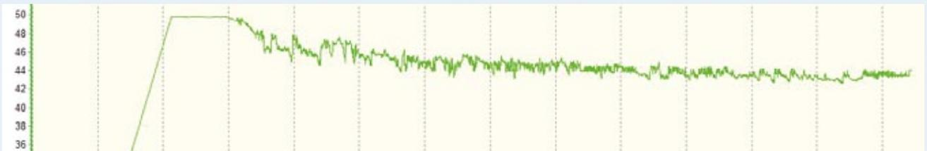
Diagramm Spannungslage: Der gleiche Flug wie beim Diagramm Entladung, hier jedoch nur die Gesamtspannung des 12s-Packs betrachtet. Wir liegen im Mittel bei 44 Volt, was einer mittleren Zellenspannung von 3,66 Volt unter Last entspricht
