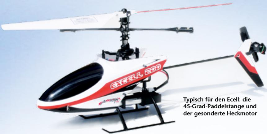
Typisch für den Ecell: die 45-Grad-Paddelstange und der gesonderte Heckmotor
