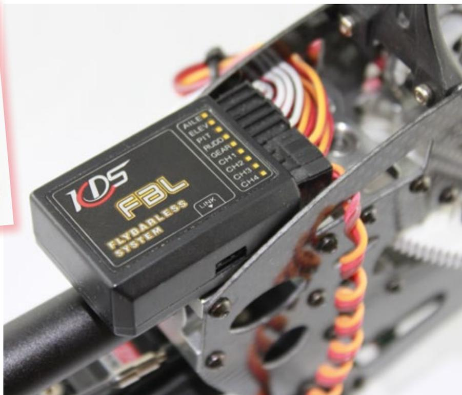
Tadellose Funktion und einfache Programmierung, das KDS Dreiachs-Flybarless-System. Die Unterbringung des Gehäuses ist nicht optimal – es steht weit nach hinten, obwohl vorne noch Platz wäre. Der Grund: Die seitliche Anschlussbuchse des Bedienteils muss zugänglich bleiben
