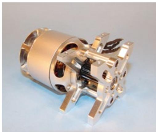
Die komplette Motoreinheit lässt sich mitsamt dem Gegenlager im Chassis verschieben
