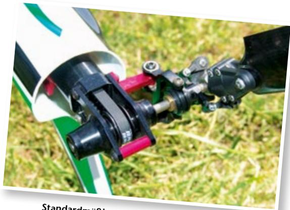
Standardmäßig erfolgt der Antrieb des Heckrotors über Zahnriemen, der innerhalb des Heckrohrs geführt wird. Das Heckrohr selbst ist im Heckausleger vibrationsgeschützt befestigt. An der rechten Seite des Auslegers ist die aerodynamisch wirkende Kante erkennbar (siehe Text)
