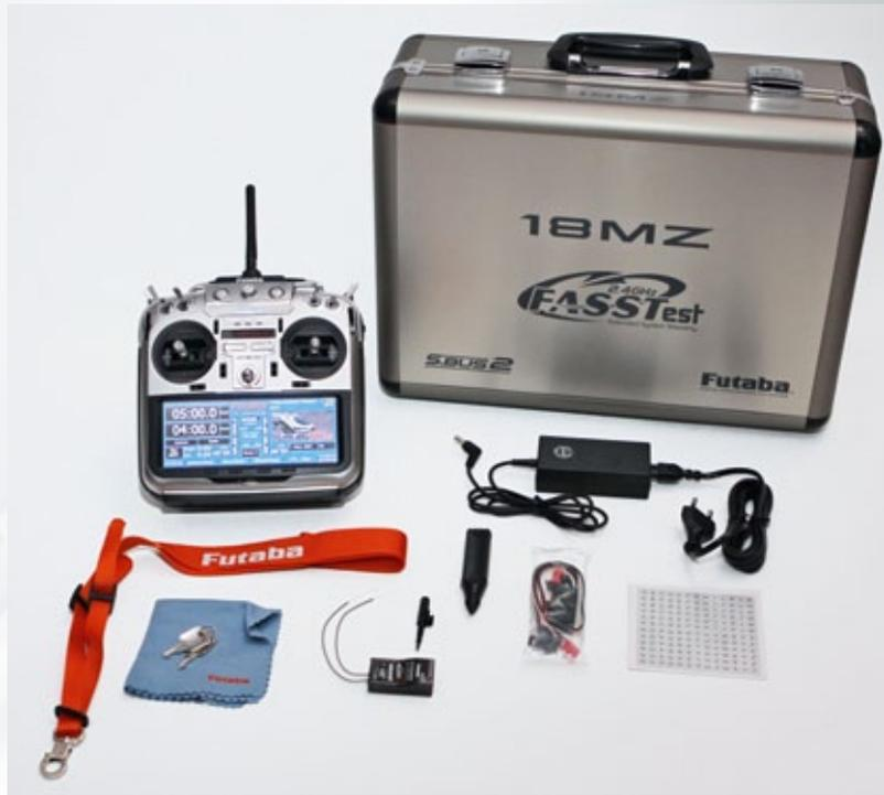
**Lieferumfang:** So präsentiert sich die T18MZ samt Zubehör. Der schwarze „Stift“ ist ein Multifunktions-Tool, unter dessen Gummispitze sich eine Art Steckschlüssel zum Versetzen der Schalter befindet. Im Inneren sind zwei kleine Inbus-Schlüssel untergebracht, als Ganzes kann der Stift den Touchscreen bedienen
