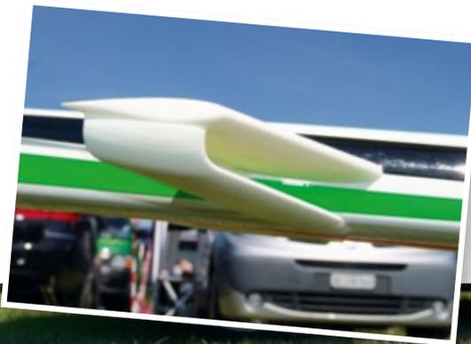
Absolute Seltenheit, wenn nicht sogar Premiere: ein Höhenleitwerk in Doppeldecker-Ausführung. Dahinter steckt die Idee, ein möglichst effizientes Profil mit einer sehr kleinen projizierten Fläche zu kombinieren. Ergebnis: Der Rumpf flippt super, ist damit wendig und fliegt trotzdem noch schnurgeradeaus
