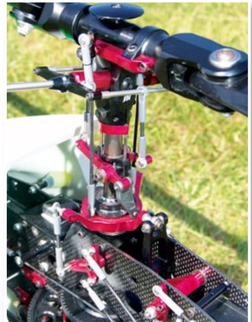
Das bewährte JR-Hauptrotorsystem mit seiner 120-Grad-Taumelscheiben-Anlenkung und untenliegender Stabstange
