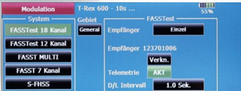
Eine der großen Neuerungen, die mit der T18MZ einhergehen, ist die Einführung der FASSTest-Modulation, welche Telemetrie ermöglicht. Worin genau der Unterschied zwischen FASSTest 12 und FASSTest 18 besteht, klären wir im Text
