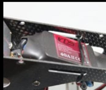
Details von einigen der im Heli verbauten RC- und Antriebskomponenten. Im Bild ganz rechts der unter der Akkurutsche verbaute KDS-40-Ampere-Controller
