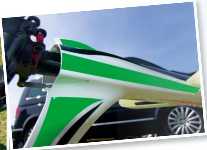
Wer genau hinschaut, erkennt an der in Flugrichtung gesehenen rechten Seite des Heckrotors eine Anformung am Rumpf. Diese Kante dient zur Erhöhung der Heckrotorleistung. Hier steckt jede Menge aerodynamisches Know-how aus der realen Luftfahrt dahinter
