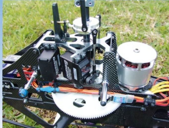
Weil das 2012er Carbon-Chassis des 7HV auf Höhe des Motors keine Abstreifung mehr nach vorne besitzt, können größere Antriebe verbaut werden. Man beachte den JLog von SM-Modellbau, der die Daten des Heli JIVE direkt per Graupner HoTT-Telemetrie auf das Senderdisplay bringt
