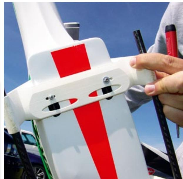
Eine breite Auflagefläche sowie Langlöcher ermöglichen eine variable Befestigung der Kufenbügel unter dem Rumpf, um sie mit den verschiedensten Mechaniksystemen adaptieren zu können
