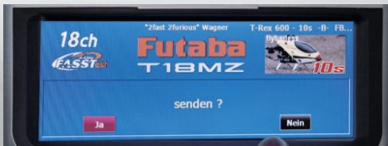
Auf vielfachen Wunsch wurde die Abstrahl-Abfrage nach dem Hochfahren nun entfernt; für 2G4 sicherlich sinnvoll. Damit der Reichweitentest im System-Menü funktioniert, darf der Sender jedoch zunächst nicht senden. Um das zu erreichen, muss während des Hochfahrens S4 gedrückt bleiben, dann erscheint der altbekannte Dialog wieder
