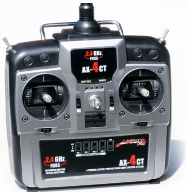
Der beigefügte Fünfkanal-Sender überrascht durch präzise Knüppelaggregate und hohe Reichweite. Es handelt sich um einen Frequency-Hopper, wie das Spektrum-Diagramm verdeutlicht
