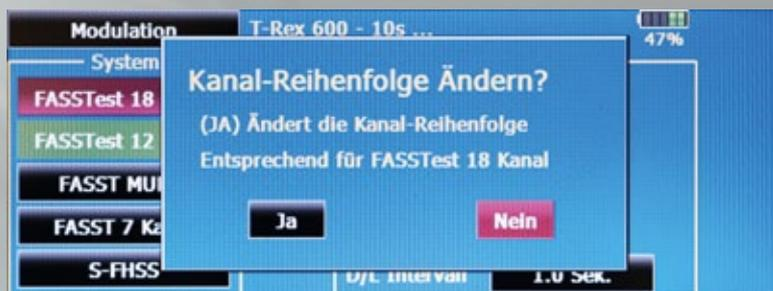
Nichts ist lästiger, als wenn sich beim Empfängerwechsel auch noch die Reihenfolge der Kanäle ändert. Um die Servos 1:1 umstecken zu können, einfach die Frage nach Änderung der Kanal-Reihenfolge guten Gewissens mit „nein“ bestätigen
