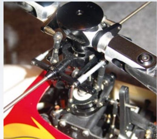
Das Hauptrotorsystem des E-Rix 500 Carbon ist überwiegend in Aluminium ausgeführt, was die Konstruktion stabil, drehzahlfest und verwindungssteif macht. Sogar die Steuerkulisse der Stabilisierungsstange ist in Metall ausgeführt
