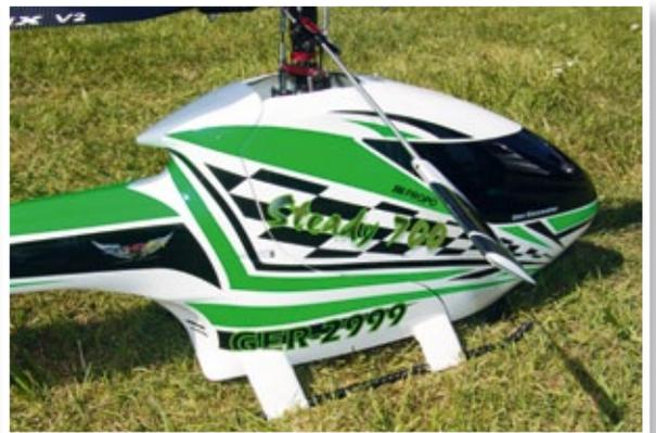
Bei der computerunterstützten Entwicklung des Steady 700 wurde großer Wert darauf gelegt, dass der Widerstand der Zelle aus allen erdenklichen Richtungen ähnlich groß ist
