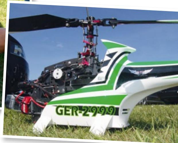
Die Fronthaube ist abnehmbar gestaltet und ermöglicht beste Zugänglichkeit zur Mechanik. Die besondere Gestaltung der Trennebene, die auf den beiden Bildern mit der demontierten Haube erkennbar ist, sorgt für perfekten Sitz. Die Befestigung erfolgt über zwei Schrauben
