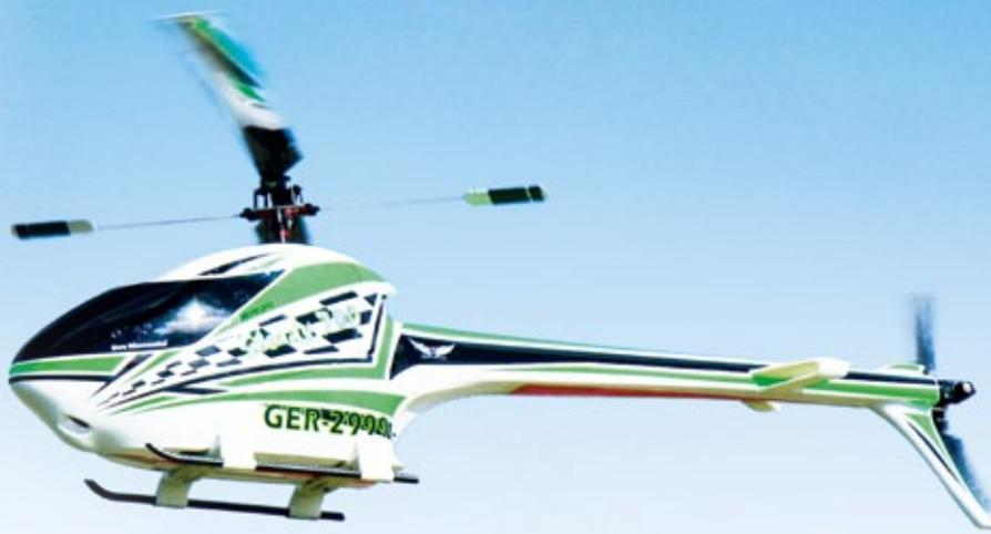
Nicht vergessen darf man die kleine Kante im Bereich des Heckrotors. Sie dient zur Erhöhung der Heckrotorleistung. Hier steckt jede Menge aerodynamisches Know-how aus der realen Luftfahrt dahinter. Ein weiteres Schmankerl sind die mit aerodynamischen Profil versehenen Kufen mit integrierten Lufteinlässen (hinten).
