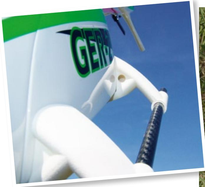
Auch das Kufengestell wurde komplett neu konzipiert. Die hinteren Kufenbügel verfügen sogar über integrierte Lufteinlässe, zudem sind sie aerodynamisch profiliert
