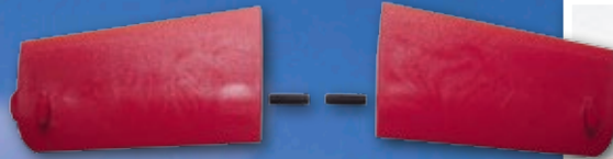
Die beiden Höhenleitwerke mit den Gewinde-Inserts vor dem Einbau ...
