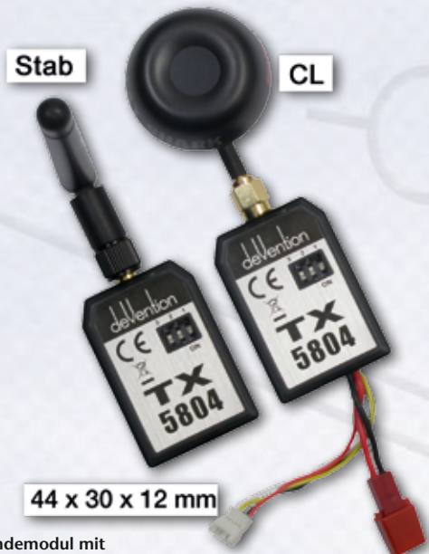
Sendemodul mit Stromversorgung für die Kamera von Walkera
