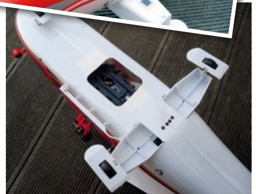
Blick auf die Unterseite mit dem an der Mechanik verschraubten Hauptfahrwerk
