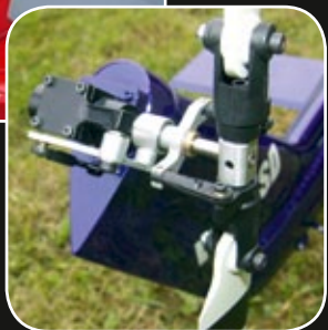
Der Heckrotor der Bell 412, gefertigt von Richard Mittermeier. Im Heckausleger kommt noch ein 45-Grad-Winkelgetriebe zum Einsatz
