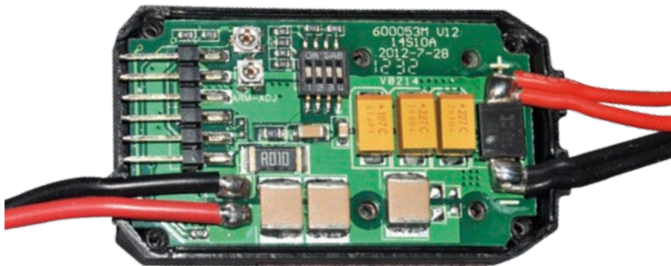
Die Bestückungsseite des SkyRC Super BEC mit den sauber verlöteten Kabelanschlüssen auf der Platine
