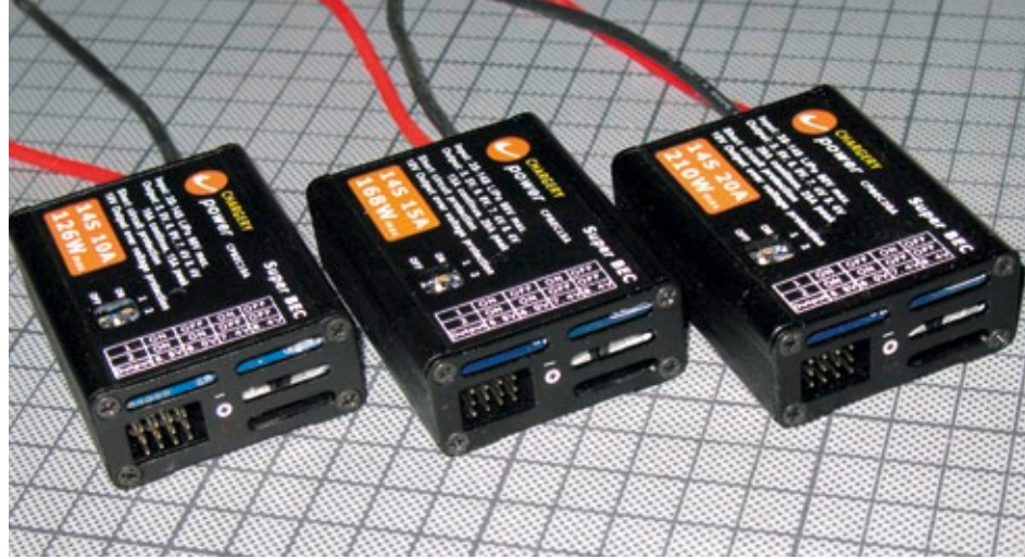
Die Chargery Power Super BEC's mit 10, 15 und 20 Ampere Dauerleistung
