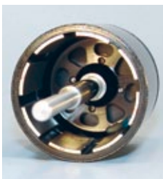
Die mit acht Magnetstäben beklebte Glocke besitzt an der Stirnseite einen angedrehten Bund, der die schalenförmigen Magnete einfasst und die offene Seite der Glocke zusätzlich stabilisiert
