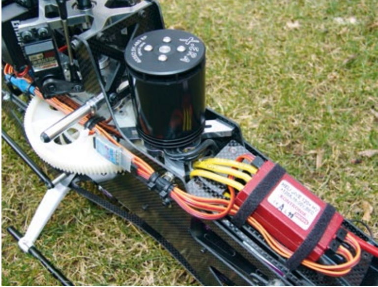
Der X-ERA wird von einem Kontronik Heli JIVE 120+ angesteuert und läuft im Compass 7HV bei 12s mit beeindruckend hohem Wirkungsgrad
