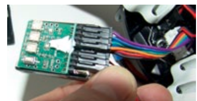
Blick ins Innere der FC430. Deutlich zu erkennen sind die drei Potis für Empfindlichkeitsverstellung, die man jedoch auf den Werkeinstellung stehen lassen sollte
