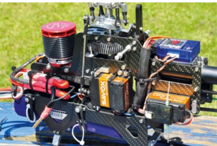
Gesamtansicht der linken Chassishälfte mit den im Chassis verbauten Savöx-Servos und dem am Heckservo befestigten Satelliten
