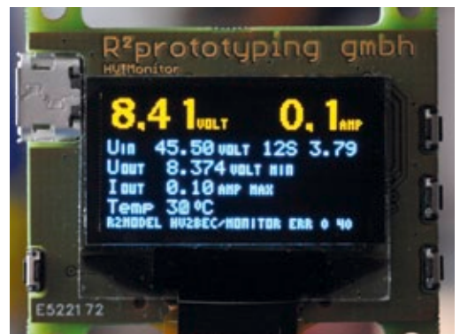
Das superscharfe OLED-Monitor-Display lässt sich an beide HV2BEC`s anstecken
