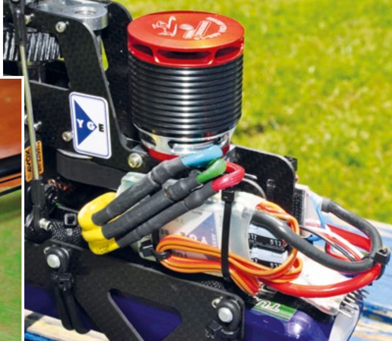
Eine saubere Kabelverlegung ist enorm wichtig. Gut zu sehen sind die hervorragenden Savox-Servos von RC-City. Der YGE-Controller ist geschützt an der Seitenplatte untergebracht
