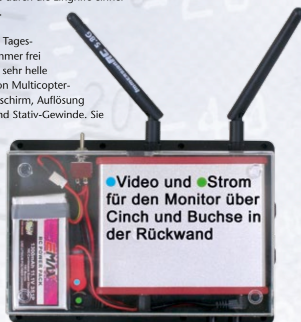
GlobeFlight Monitor zur FPV-Station ausgebaut
