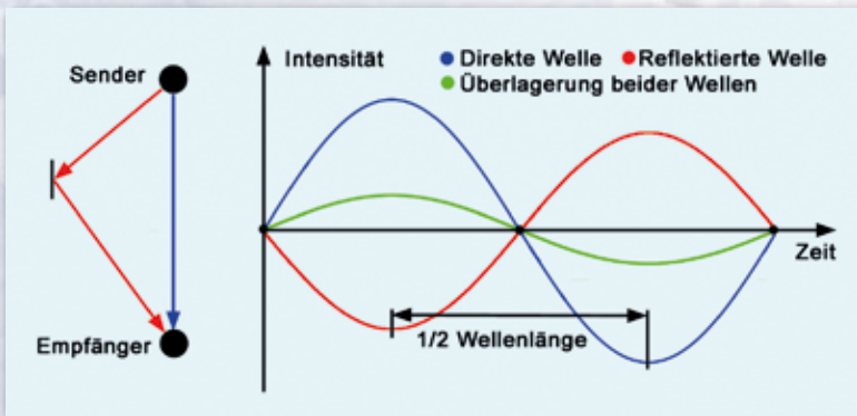
Abbildung 7: Direkte und reflektierte Wellen können sich ungünstig überlagern
