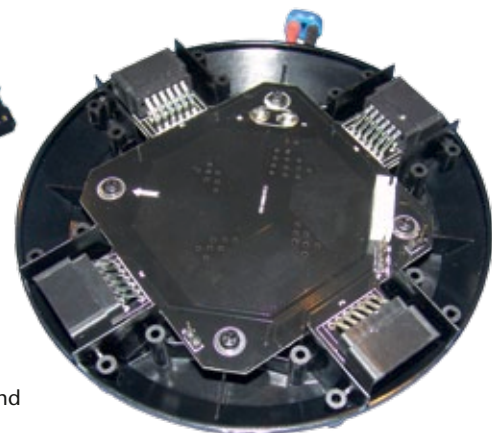
Das Mainframe ist bereits vormontiert und beherbergt unter anderem die Zentralplatine, die auch für die Stromverteilung zu den einzelnen Auslegerarmen verantwortlich zeichnet
