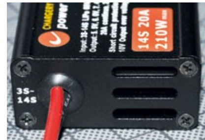
Rückseite der Chargery BEC's mit Lüftungsschlitzen
