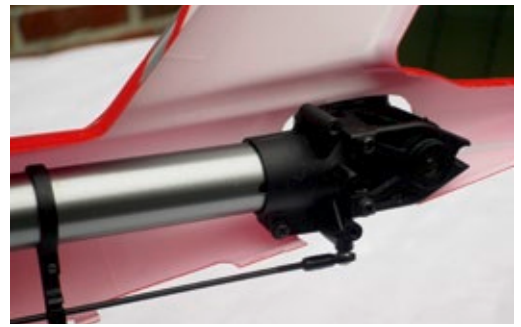
Sehr wichtig ist unter anderem auch eine genügend große Aussparung fürs Heckgestänge, das nirgendwo scheuern oder anschlagen darf
