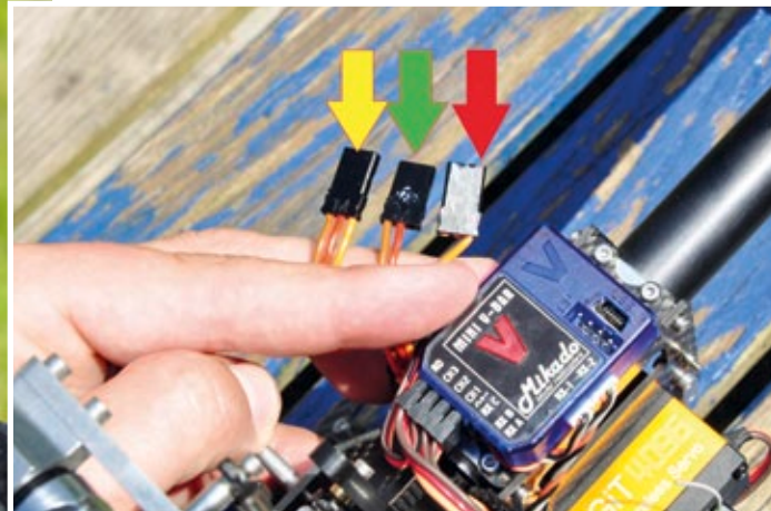
Die drei notwendigen Kabel vor der Belegung am Mini-V-Stabi. Rot = Drehzahlreglung, Grün = Slave-Versorgung, Gelb = Masterkanal vom YGE 90LV
