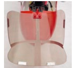
Die Frontverglasung mit den aufgeklebten Metallstreifen zur Befestigung
