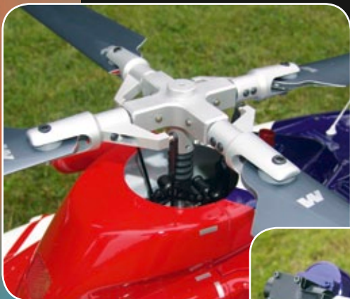
Das Vierblatt-Hauptrotorsystem mit seinen gedämpften Blatthaltern stammt von Peka Lufttechnik
