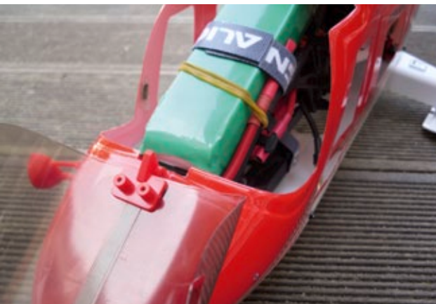
Mit Hilfe des zentral montierten Scharniers lässt sich die Verglasung für den Akkuzugang öffnen und schließen
