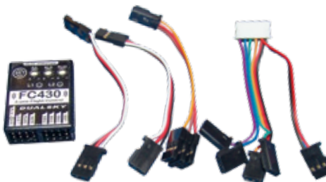
Die Dreiachs-Lageregelung inklusive Bordelektronik mit den Kabelbäumen
