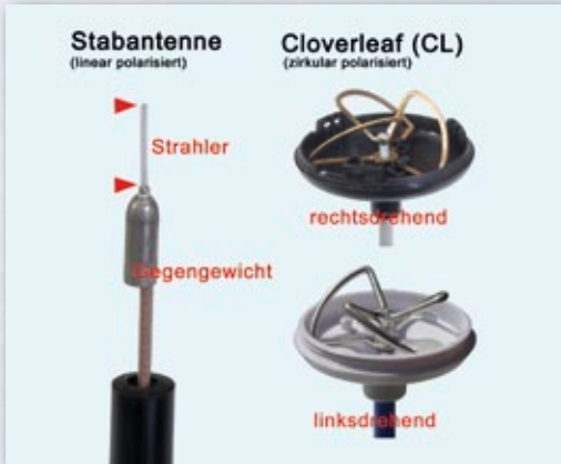
Abbildung 2: Aufbau von Antennen. Links/rechtsdrehend dürfen nie kombiniert werden
