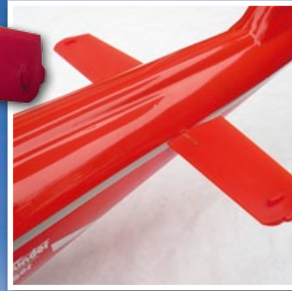
... und hier fertig montiert am Rumpf. Die Gewinde-Inserts wurden zuvor in der Heckrohr-Halterung verschraubt
