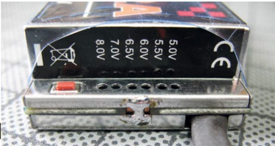
Nach längerem Druck auf den roten Tastschalter kann mit jedem weiteren Tastimpuls eine von sechs unterschiedlichen Ausgangsspannungen gewählt werden, was durch jeweils eine LED angezeigt wird. Nach einem weiteren längeren Druck ist diese dann fest eingespeichert
