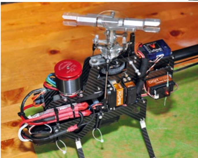
Voodoo 400 bei seinem ersten Probelauf. Achtung: Aus Sicherheitsgründen sollte man das Abschrauben der Blätter nicht vergessen
