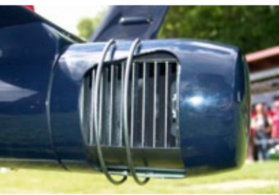
Der Notar mit seiner drehbaren Steuertüte, durch die der Luftstrom umgelenkt wird
