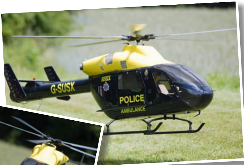
Die neue MD 902 Explorer im Maßstab 1:6 mit Pyro 700-Antrieb
