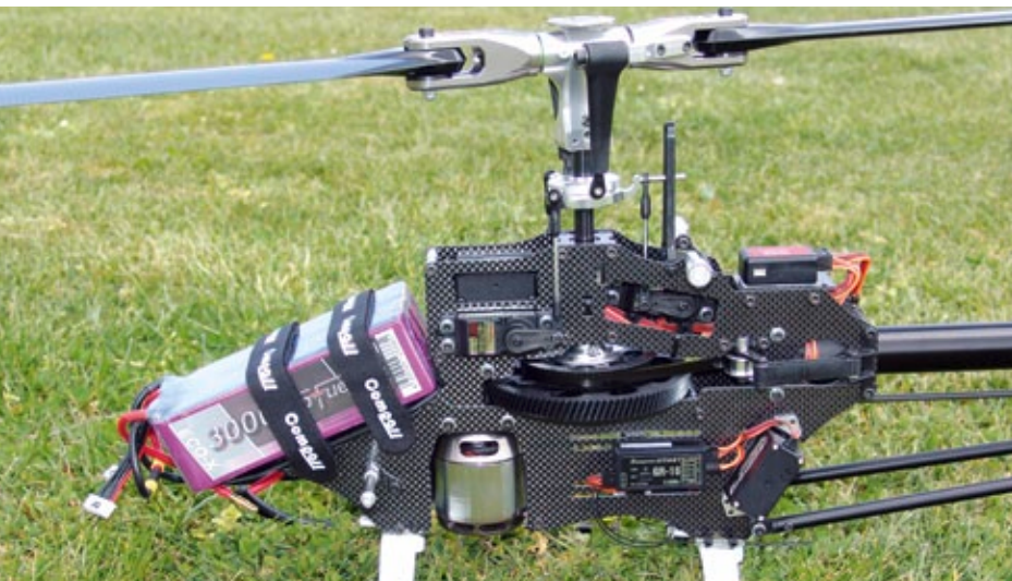
Empfänger und Heckrotorservo sitzen im linken Seitenteil. Der Motor bleibt für eine bessere Kühlung frei. Hinten ist der Riemenspanner zu erkennen
