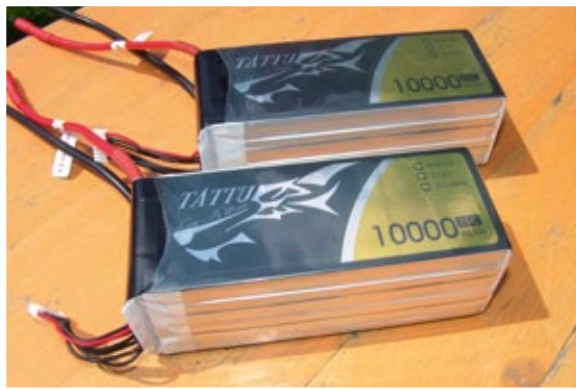
Die Stromversorgung der MD 902 Explorer besteht aus zwei 6s-Packs
