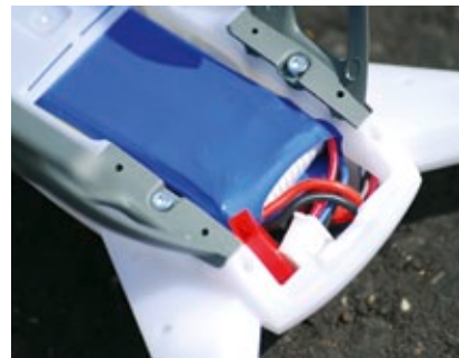
So geht's am besten: Akku einschieben, anschließen und Kabel sorgfältig verstauen. Der Deckelverschluss muss einrasten
