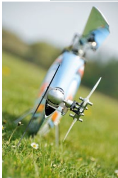
Der Heckrotor mit den 95 mm langen Kunststoff-Heckblättern. Gut zu erkennen sind die Propeller-Momentgewichte
