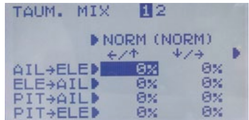
Frei programmierbare Taumelscheiben-Mischer stehen zur Verfügung, mit denen sich auch eine virtuelle Taumelscheibendrehung bewerkstelligen lässt
