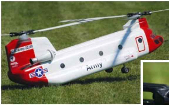
Der mit Dreiblattrotoren und Pyro 850 ausgestattete Tandemhubschrauber Chinook, für dessen Flugsteuerung das neue BavarianDemon 3SX „Tandem“ verantwortlich zeichnet
