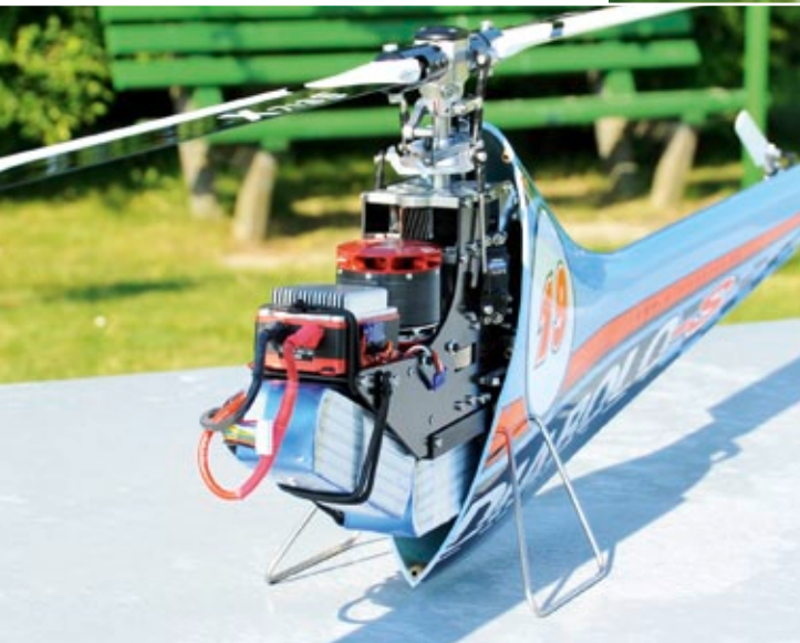
Deutlich zu erkennen – die Anordnung der LiPo-Packs
