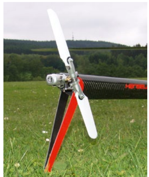
Detail der Heckrotoraufnahme mit dem doppelt ausgeführten Seitenleitwerk
