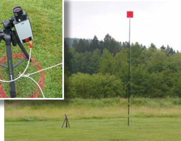
Blick auf den rechten Pylon, unmittelbar davor die nach oben gerichtete Kamera zur Erfassung der sich bewegenden Flugobjekte
