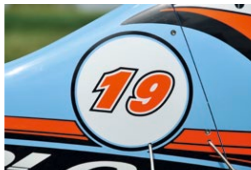
Deutlich zu erkennen sind die Haubenverschraubungen und die Kufen-Drahtbügel
