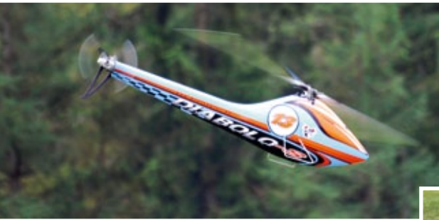
Der Diabolo 5 des Zweitplatzierten Miles Dunkel, ausgestattet mit einem X-Nova XTS 4535-500 und einem Controller YGE 320 HV mit 14s-LiPos. Die kleine Luftschraube auf dem Motor dient zur Luftströmung innerhalb des Rumpfs
