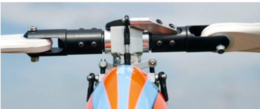
Der kompakte Zweiblatt-Hauptrotorkopf, hier bereits mit den verstärkten Blatthaltern
