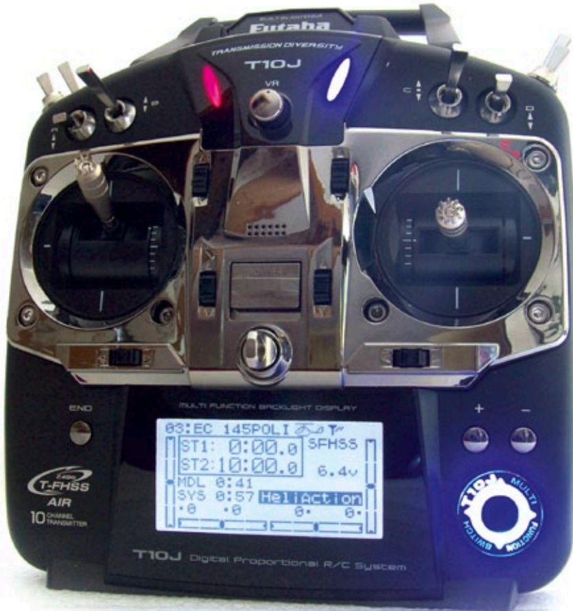
Viel Licht: hintergrundbeleuchtetes Display, rote und blaue LED im oberen Bereich sowie der illuminierte 3D-Hotkey
