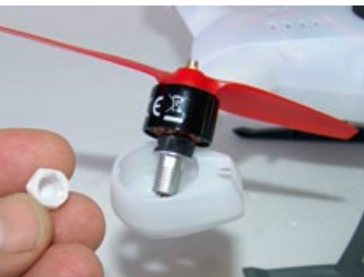
Nach dem Lösen der Muttern lässt sich der BL-Motor herausnehmen
