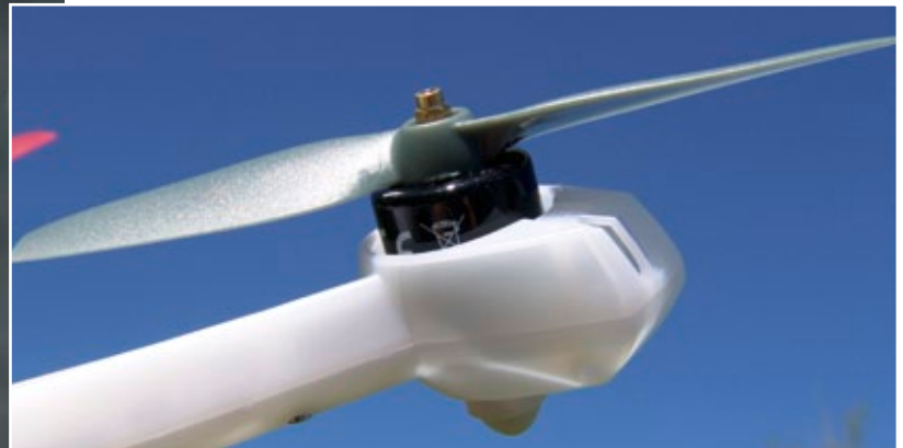
Die kräftigen Brushless-Außenläufer sitzen in stromlinienförmig gestylten Gondeln
