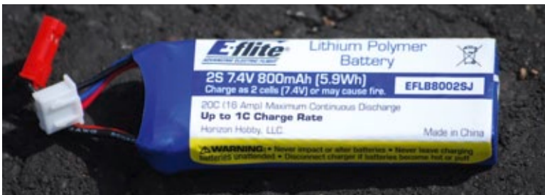
Mit dem 2s-LiPo sind maximal etwa 9,5 Minuten Flugzeit möglich
