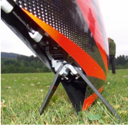
Blick auf die beiden Kufenbeine, die eingeklapppt werden können
