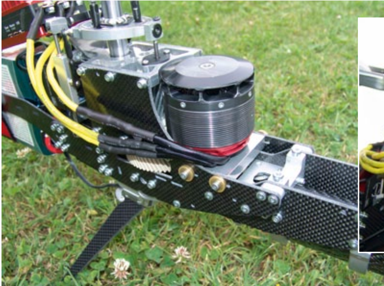
Markant an der TDS-Mechanik – der hinten sitzende Motor. Erkennbar ist der Mechanik-anbau zur Heckrohraufnahme, der aus CFK-Platten und Alu-Formteilen besteht
