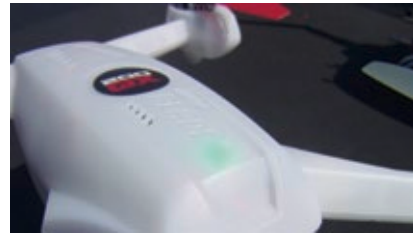
Auch bei Sonnenlicht ist die Betriebs-LED innerhalb des Korpus erkennbar – hier grün, Modus 1/Einsteiger
