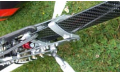
Die beiden Alu-Heckrohr-Aufnahmen sind der Kontur des Heckrohrs genauestens angepasst
