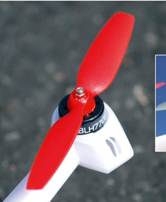
Die kräftigen Brushless-Außenläufer sitzen in stromlinienförmig gestylten Gondeln
