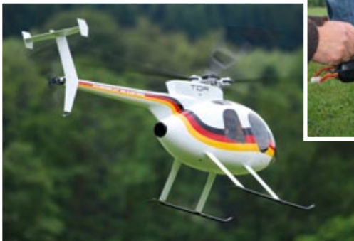
Das einzige Scale-Modell, das beim Speed-Cup mitwirkte: die Hughes 500 (Witte-Bausatz) mit TDR-Mechanik und Fünfblatt-Hauptrotor von Friedrich Stapf, übrigens mit 67 Jahren der älteste Teilnehmer
