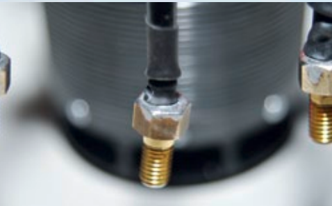
Die verlöteten Anschlusschrauben – bereit zur Montage
