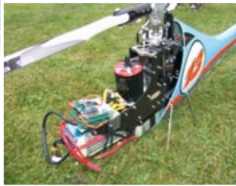
Der Diabolo 5 des Zweitplatzierten Miles Dunkel, ausgestattet mit einem X-Nova XTS 4535-500 und einem Controller YGE 320 HV mit 14s-LiPos. Die kleine Luftschraube auf dem Motor dient zur Luftströmung innerhalb des Rumpfs
