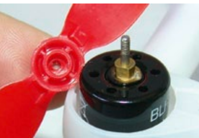
Die Mitnahme der Props wird durch Abflachungen auf der Welle gewährleistet
