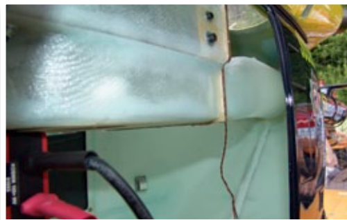
Der Gebläsekanal besteht aus GFK und dient zur Luftführung
