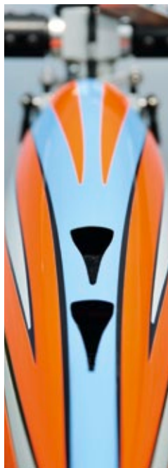
Die Kühlluft-Öffnungen im Rumpf sind unbedingt nötig
