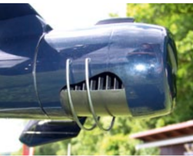
Der Notar mit seiner drehbaren Steuertüte, durch die der Luftstrom umgelenkt wird
