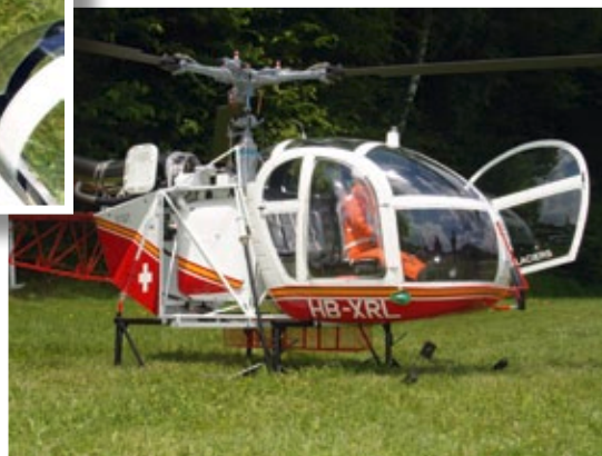
Das Siegermodell bei der Baubewertung – die Vario Lama SA315 B von Jörg Rabenstein, ausgerüstet mit einer Jakadofsky Pro 5000 und einem Abfluggewicht von 23 Kilogramm
