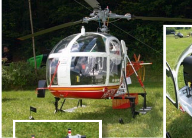
Das Siegermodell bei der Baubewertung – die Vario Lama SA315 B von Jörg Rabenstein, ausgerüstet mit einer Jakadofsky Pro 5000 und einem Abfluggewicht von 23 Kilogramm
