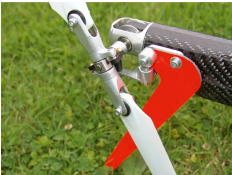
Detail der Heckrotoraufnahme mit dem doppelt ausgeführten Seitenleitwerk
