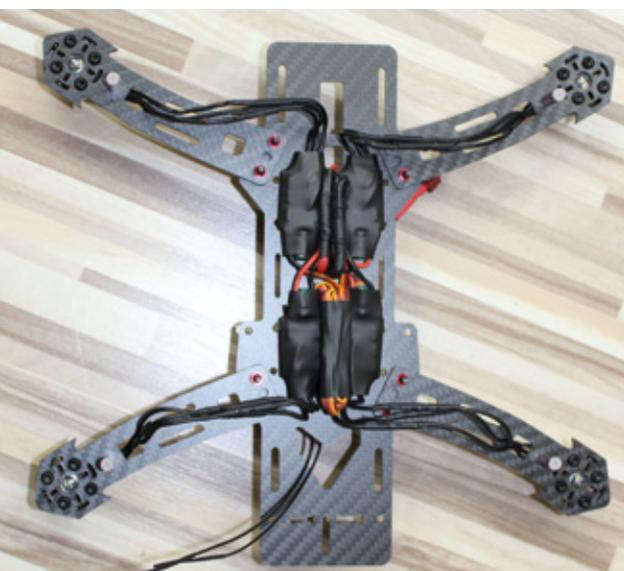
Die Controller werden unten im Chassis verstaut. Hier geht es eng zu, sodass mit der Kabel-Verlegung geschickt vorgegangen werden muss
