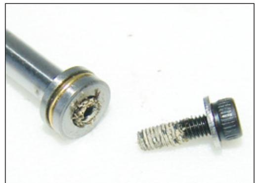
Jetzt ist Reinigen angesagt. Da wir die Schrauben und Drucklager noch benötigen, sollte man diese vor dem Einsatz im Dreiblatt gründlich von alter Schraubensicherung befreien und reinigen
