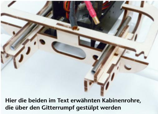
Hier die beiden im Text erwähnten Kabinenrohre, die über den Gitterrumpf gestülpt werden
