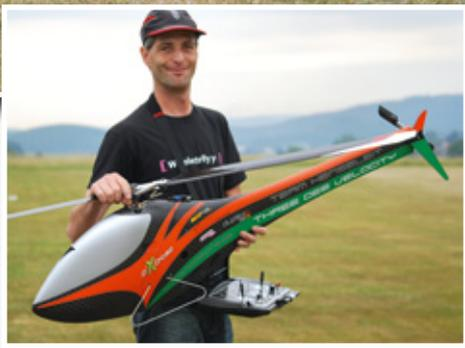
Wie bereits im Vorjahr, gewann auch diesmal Robert Sixt mit seinem TDR Velocity. Die Daten: Kontronik Pyro 850-50, Controller Kontronik Cool Kosmik 200, LiPo-Flugakkus SLS 14s/4.400 mAh 45C, Servos Taumelscheibe X950BLHV
