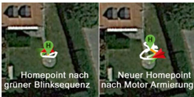
Wichtig ist nur der Homepoint nach Motor-Armierung. Das GPS zeigt eine erstklassige Genauigkeit mit bis zu 17 GPS/GLONASS-Satelliten
