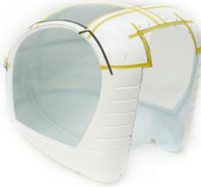
Auch der Heckbereich der Kabine muss entsprechend den Konturen der T-Rex-Mechanik ausgeschnitten werden
