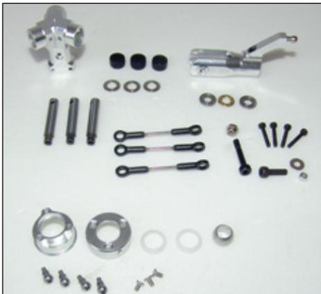
Zuerst sollte man sich einen Überblick verschaffen, was dem Conversion-Set von Horizon Hobby alles beiliegt. Im unteren Bildbereich befinden sich der Taumelscheiben-Innenring nebst Kugel und Lagerung. Darüber das Dreiblatt-Zentralstück mit gehärteten Blattlagerwellen, kompletter Dämpfung, einem Blatthalter (identisch mit Zweiblatt) sowie Lagerungen und Befestigungen
