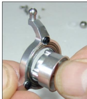
Dreiblatt-Innenring von unten in die Taumelscheibe einsetzen. Bis zum Anschlag andrücken
