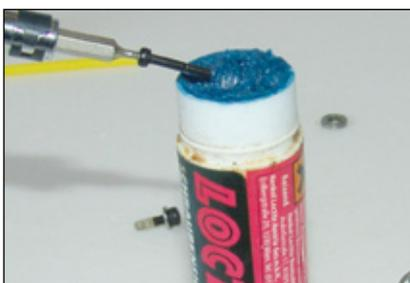
Hierzu empfiehlt sich beispielsweise entsprechende Sicherungs-Paste, die man auf das entfettete Gewinde der Schraube aufbringt
