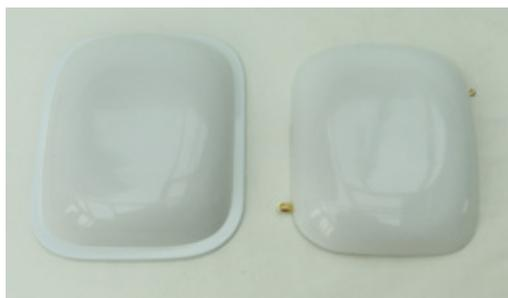
Links die originale Tankatrappe, daneben die modifizierte, nun passende Version mit den beiden eingearbeiteten Befestigungsösen (siehe Text)
