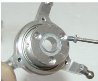
Drei Senkkopfschrauben dienen zur Befestigung des Innenrings auf seinem Unterteil. Unbedingt hier wieder Schraubensicherung verwenden!
