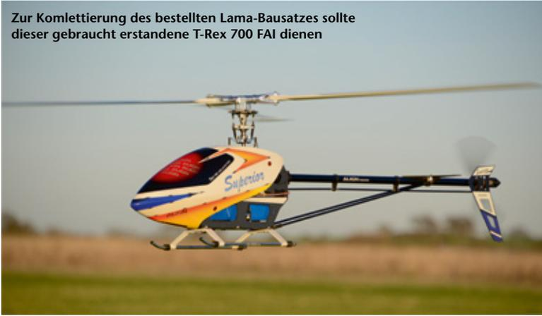
Im T-Rex 700 ist serienmäßig ein 12-Zähne-Ritzel in Verbindung mit einem Hauptzahnrad mit 112 Zähnen verbaut. Eine schnelle Überschlagsrechnung ergab bei der Nutzung des empfohlenen 12s-LiPos eine zu erwartende Maximal-Hauptrotordrehzahl von etwa 1.900 Umdrehungen pro Minute (U/min) und eine Minimum-Drehzahl von 1.400 U/min oder gar noch weniger. Das alles schien mir für mein Vorhaben in Kombination mit dem unkomplizierten und auch bei Wind bestens beherrschbaren Paddelrotor perfekt zu sein.
