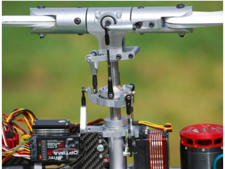
Neuartiges Rotorkopf-Konzept mit einer 12er-Rotorwelle und einer 10er-Blattlagerwelle mit M8-Außengewinden. Markant ist das Rotorkopf-Zentralstück. Hier sitzt ...
