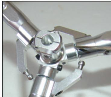
Kontrolle der Leichtgängigkeit der Drehbewegung der Blatthalter, ebenso der Abstände von Blatthalter zu Zentralstück. Überschüssiges, aus der Dämpfung austretendes Fett kann entfernt werden
