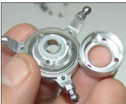
... obere Teflonschale unter Fettzugabe einsetzen. Auch der Dreiblatt-Innenring liegt schon bereit und wird anschließend von oben über das Ganze gestülpt.
