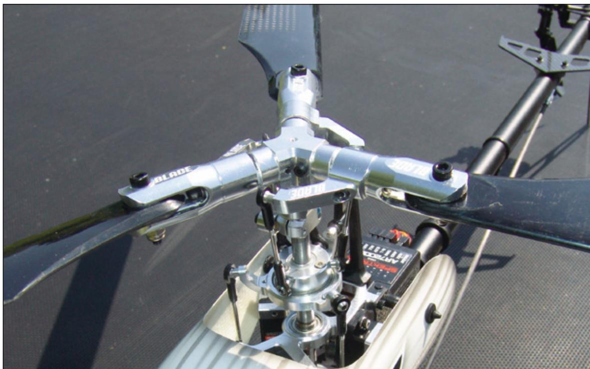
Das war's. Mit ein wenig handwerklichem Geschick lässt sich der gesamte Umbau in weniger als einer Stunde bewerkstelligen, sodass es zügig zum Einfliegen gehen kann. Hierbei beachten: Spurlauf kontrollieren, Drehzahl gegenüber der vorhergehenden Zweiblatt-Version reduzieren und sich langsam mit dem neuen Fluggefühl vertraut machen. Ihr werdet sehen: Der Sound und die Performance des Dreiblatts werden auch Euch in den Bann ziehen. – Viel Spaß beim Umrüsten und beim Fliegen
