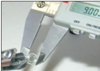
Vom Drucklager die innere Lagerscheibe – das ist die mit dem größeren (9 mm) Außendurchmesser – in den Blatthalter einsetzen
