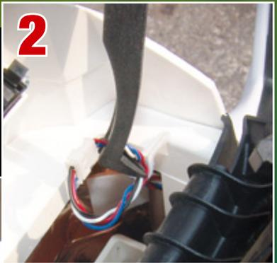
Kabel so weit herausziehen, dass die Steckverbindung zugänglich ist
