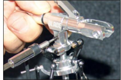
Nach dem Abklippen der beiden Rotorkopf-Gestänge sowie der beiden Y-Mitnehmer-Kugelgelenke wird die Rotorkopf-Querschraube gelöst
