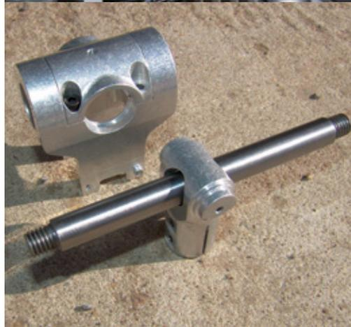
... das äußere Zentralstück schwenkbar auf dem inneren, fest mit der Rotorwelle verbundenen Zentralstück, wobei die Blattlagerwelle in Kugellagern gelagert ist. Die Dämpfung erfolgt über Gummieinsätze im äußeren Zentralstück, die direkt auf die Rotorwelle drücken
