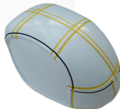
Mit Klebeband wurden die Trennlinien an der Kanzel markiert
