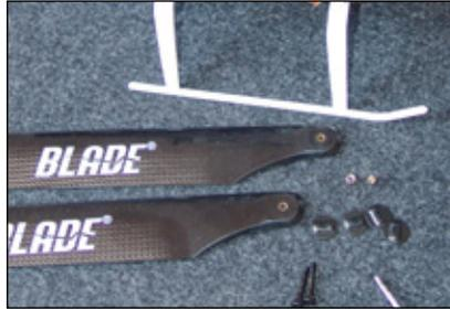
Die Rotorblätter des Zweiblatts werden demontiert. Darauf achten, dass sich in den Blattgriffen jeweils zwei Kunststoff-Adapterscheiben befinden
