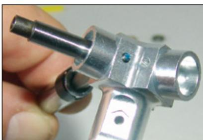
Blick auf die Gewindebohrung mit der eingesetzten Blattlagerwellen-Querschraube. Überschüssiger Sicherungskleber wird abgeputzt
