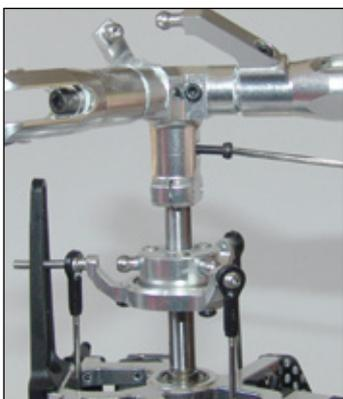
Hauptrotor auf die Rotorwelle aufsetzen, Querlöcher fluchtend übereinander bringen und Querschraube durch die Bohrungen schieben
