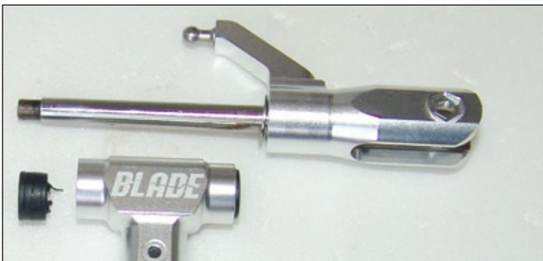
Problem jetzt: Die Schraube des anderen Blatthalters sitzt meistens noch bombenfest. In diesem Fall muss man die Blattlagerwelle am besten in einen Schraubstock spannen. Achtung: Hier keinesfalls Stahlbacken verwenden, sondern weiche Aluminium-Schutzbacken, um die Stahlwelle nicht zu beschädigen
