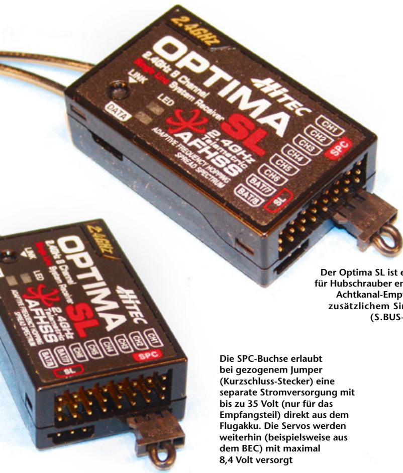
Der Optima SL ist ein speziell für Hubschrauber entwickelter Achtkanal-Empfänger mit zusätzlichem Single-Line-(S.BUS-) Ausgang
