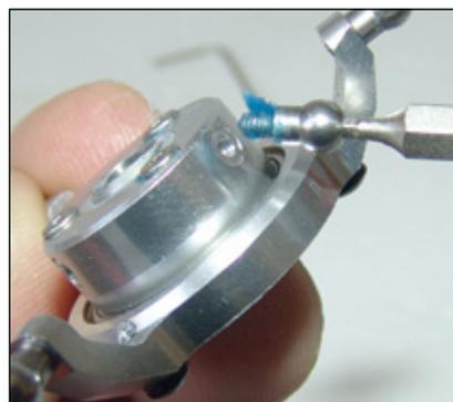
Mit dem Eindrehen der vier Kugelbolzen schließt man den Arbeitsgang an der Taumelscheibe ab, sodass ...
