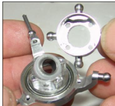
... den Innenring nebst Kugel sowie den beiden Teflonschalen entfernen
