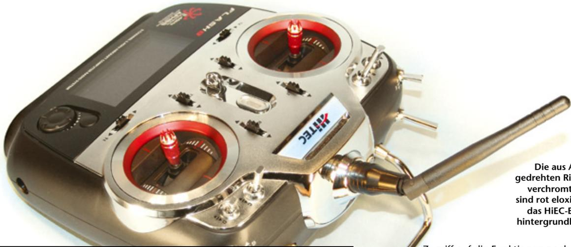
Die aus Aluminium gedrehten Ringe in der verchromten Blende sind rot eloxiert. Selbst das HiEC-Emblem ist hintergrundbeleuchtet
