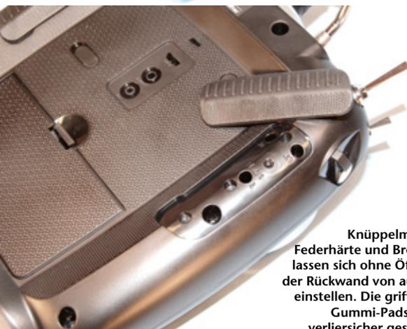
Knüppelmode, Federhärte und Bremse lassen sich ohne Öffnen der Rückwand von außen einstellen. Die griffigen Gummi-Pads sind verliersicher gesteckt
