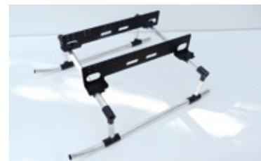
Ganz oben Größenvergleich des serienmäßigen T-Rex-Landegestells mit dem der Lama. Vor dem Verkleben des Landegestells müssen die Alu-Seitenplatten und Befestigungs-Schellen montiert werden, um die Einheit perfekt ausrichten zu können
