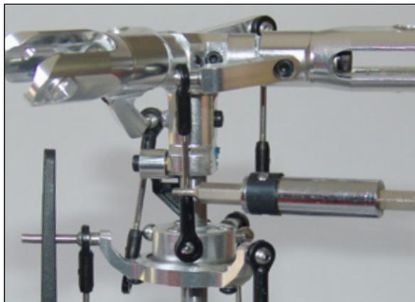
Stehen alle Gestänge senkrecht (also parallel zur Rotorwelle), ist die Position des Mitnehmerarms korrekt. Die Schraube kann festgezogen werden. Schraubensicherung berücksichtigen
