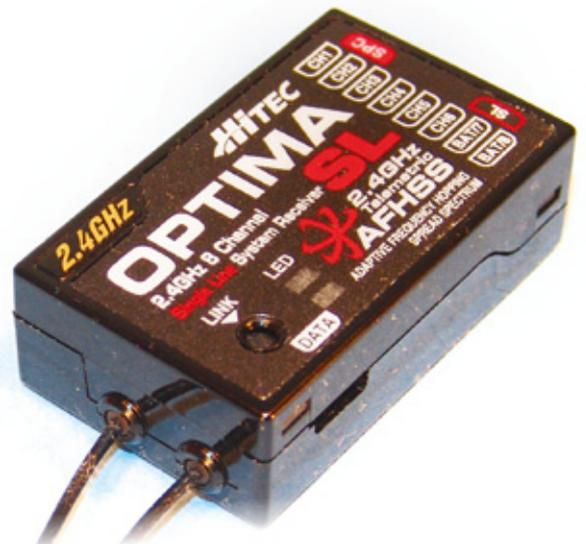
Über die seitliche Buchse (Data) können sämtliche HiTEC-Telemetrie-Sensoren angeschlossen werden. Die Koaxialkabel der Antennen sind im Gehäuse zusätzlich in Gummütüllen geführt (Reduzierung Knickgefahr)
