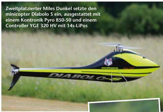
Zweitplatzierte Miles Dunkel setzte den minicopter Diabolo 5 ein, ausgestattet mit einem Kontronik Pyro 850-50 und einem Controller YGE 320 HV mit 14s-LiPos
