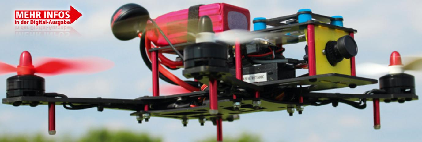
Zum Einsatz kommt das FPV-Komplettsset von Fatshark: Predator V2 mit 25-Milli watt-Sender und SpiroNet-Antennen. Mit dem Set hat man legal eine akzeptable Reichweite
