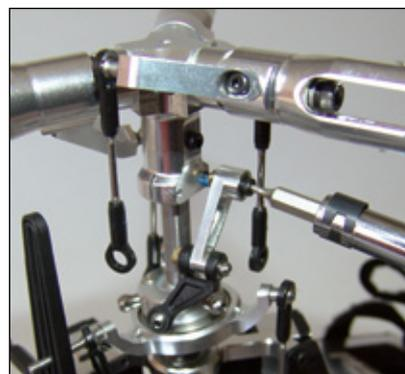
Die drei abgelängten Rotorkopfgestänge an den Blatthalterkugeln aufklipsen. Die Verstellarme befinden sich in Drehrichtung gesehen vorne. Anschließend den Mitnehmerarm am Zentralstück unter Berücksichtigung der kleinen Messing-Distanzscheibe fixieren
