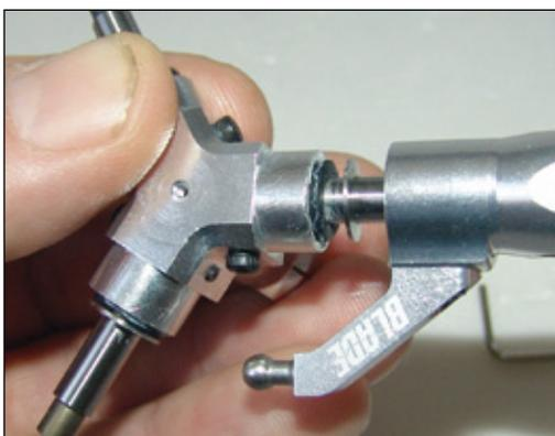
Blatthalter auf die Blattlagerwelle aufsetzen und mit dessen Hilfe den Dämpfergummi bis zum Anschlag ins Zentralstück drücken
