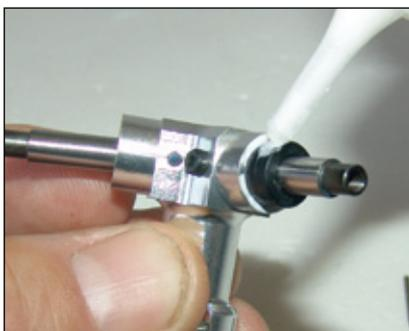
Der schwarze, dem Conversion-Set beiliegende Dämpfungsgummi wird unter Fettzugabe (hier Gear Lube) eingesetzt. Gummi in die Bohrung einschieben
