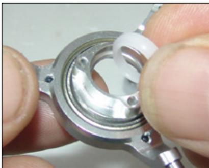
Eine der Teflon-Lagerschalen mit nach oben gerichteter Kugelausformung einsetzen
