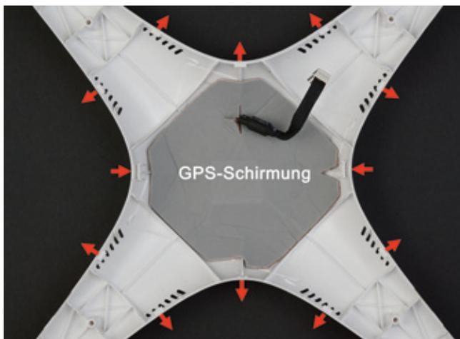
Der GPS-Empfänger befindet sich im Deckel. Die Pfeile markieren die Druck/Zugrichtung an der Oberschale zum Öffnen, wovon wir aber dringend abraten
