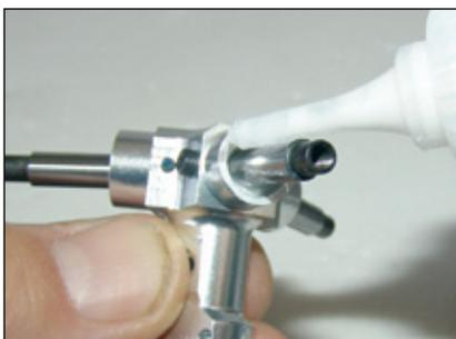
Nachdem alle drei Blattlagerwellen mit dem Zentralstück verschraubt sind, versieht man die Aufnahme für die Dämpfergummis mit reichlich Fett (trockene Gummis verschleifen frühzeitig)
