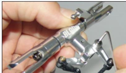
Der erste Blatthalter ist demontiert. Die unmittelbar hinter der Schraube sitzende Unterlegscheibe sowie das dreiteilige Drucklager legt man zur Seite, die in den Blatthaltern sitzenden Radiallager bleiben drin
