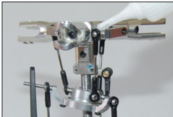
Pitch-Einstellwinkel an allen drei Blatthaltern kontrollieren (Mitte Pitchknüppel => Null-Grad-Position). Gegebenenfalls Gestängelängen korrigieren. Anschließend können die Kugelgelenke mit beispielsweise DryFluid Heli versehen werden, um deren Leichtgängigkeit zu gewährleisten
