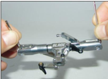
Mit zwei Inbusschlüsseln 2,5 Millimeter (mm) werden die beiden in der Blattlagerwelle sitzenden Blatthalterschrauben gelöst. Umgewinkelte Inbusschlüssel sind von Vorteil, um genügend Hebelarm zu haben, denn die Schrauben sind mit Sicherungslack eingesetzt und sitzen sehr fest
