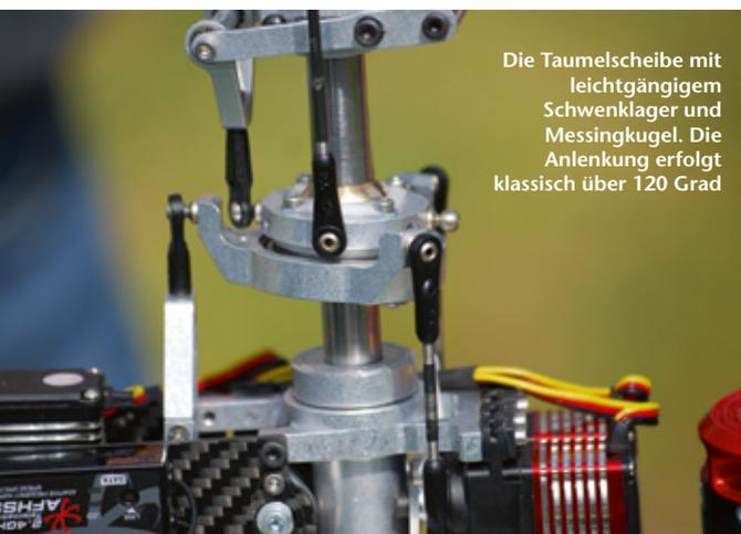
Die Taumelscheibe mit leichtgängigem Schwenklager und Messingkugel. Die Anlenkung erfolgt klassisch über 120 Grad
