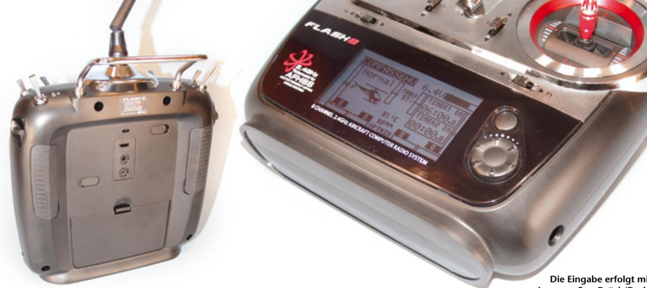
Die Rückseite ist für guten Grip der Finger optimal ausgeformt. Hier befinden sich DCS-, Lehrer-Schüler- und Daten-Buchse. Clever: Die DCS-Buchse liefert 5 Volt Output für optionales Zubehör wie beispielsweise eine Video-Brille bei FPV-Einsätzen
