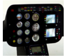
Die Instrumente sind sogar serienmäßig mit LED hintergrundbeleuchtet
