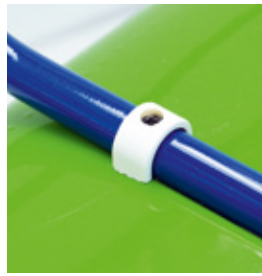
Mit vier Schrauben wird das fertige Kufenlandegestell am Rumpf montiert. Weiße Verkleidungs-Halbschalen, die aufgeklebt werden, sorgen für Scale-Look
