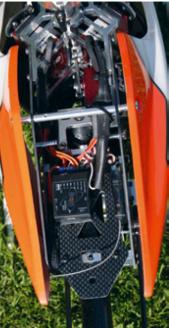
Blick auf das hinten angeordnete Brain-Flybarless-System
