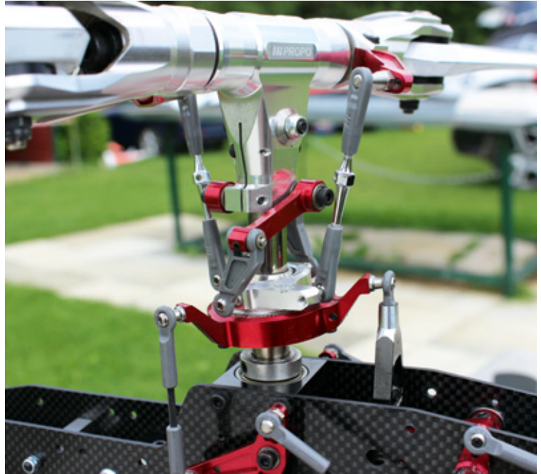
Der JR-Zweiblatt-Hauptrotor ist vollständig aus Metall gefertigt. Das Zentralstück ist im unteren Bereich geschlitzt und nimmt die Mitnehmerarme auf
