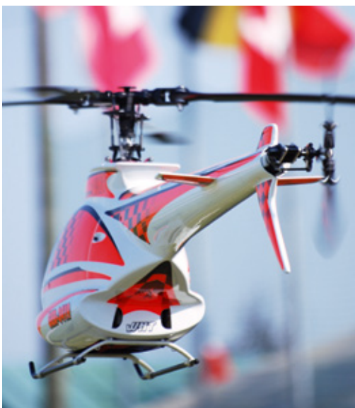
Stefans WM-Modell 2011 war seinerzeit noch gemäß FAI-Regelwerk-Vorschriften mit Stabilisierungsstange ausgerüstet
