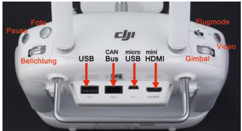
Nach Einbau der HDMI-Schnittstelle (siehe Lese-Tipp 3) kann die unübertroffene Cinemizer OLED direkt an den Sender angeschlossen werden
