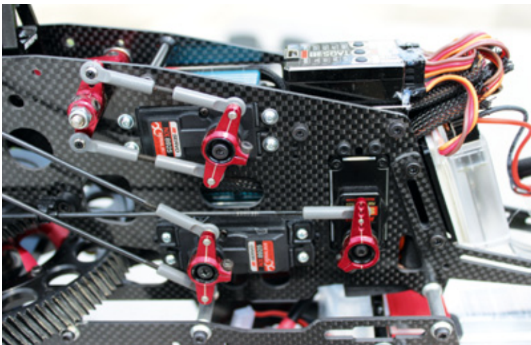
Die JR-Servos (Nick, Roll rechts und Heck) sitzen in den CFK-Seitenteilen der Sylphide-Mechanik, wobei die Taumelscheiben-Umlenkhebel über Push-Pull-Gestänge angelenkt werden
