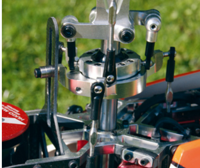
Die 120-Grad-Taumelscheibe ist ebenfalls sehr massiv. Wie schon beim E5/E7 wird sie über angeschraubte Lager geführt, die in einer Kulisserie laufen
