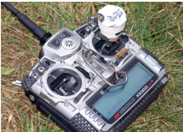
Auf Basis der X9303 von JR Propo baute seinerzeit Curtis Youngblood aus den USA seinen Sender auf diese Eigen-Design-Steuerung um (Heckrotorsteuerung über Drehrad)
