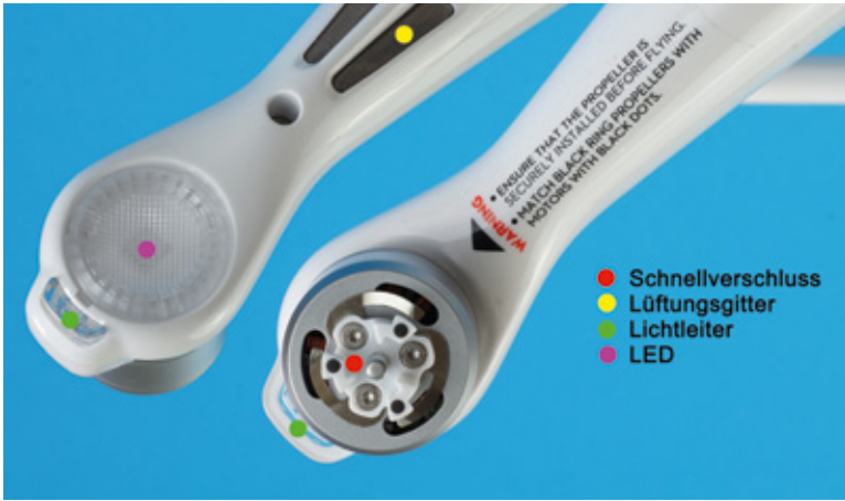
Genialer Schnellverschluss an den Motoren. Die LED sind hell – noch mehr Licht würde aber nicht schaden
