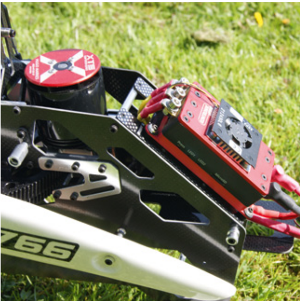
Passen sich harmonisch in die Konstruktion ein – der Xnova XT5 4535-520 und Kosmik 160 HV von Kontronik
