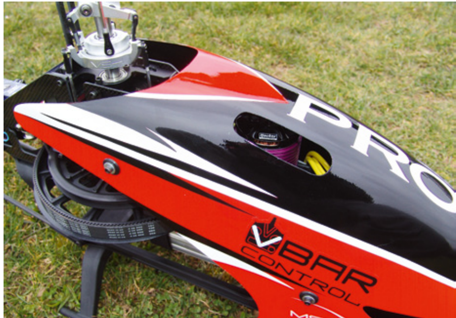
Frischluf-Öffnungen in der Kabinenhaube sind exakt auf den Motor gerichtet
