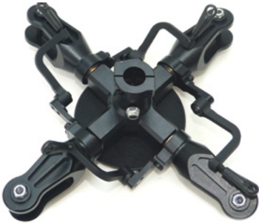
Der Vierblatt-Hauptrotor wird mit 4-Millimeter-Bolzen auf der 12er-Rotorwelle fixiert
