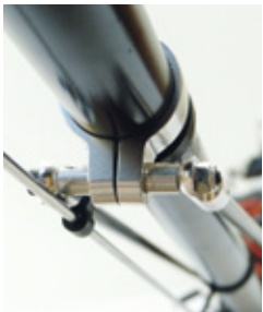
Die Heckstreben müssen mit Distanzscheiben montiert werden, sonst streifen sie am Heckrohr
