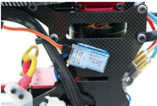
Das bewährte JLog zur Ermittlung der Controller-Echtzeitdaten ist am linken Seitenteil befestigt
