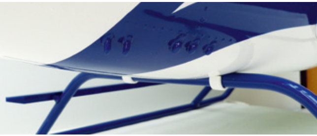
Mit vier Schrauben wird das fertige Kufenlandegestell am Rumpf montiert. Weiße Verkleidungs-Halbschalen, die aufgeklebt werden, sorgen für Scale-Look
