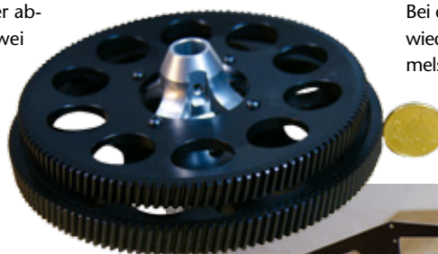
Das Haupt- und das Heckabtriebs-Zahnrad sind wesentlich massiver als beim E7 SE und überzeugen durch einen sauberen Rundlauf
