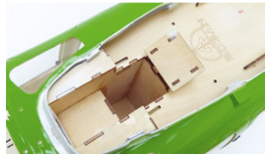
In der hier geöffneten „Besenkammer“ (siehe Text) lässt sich einer der beiden 6s-LiPos unterbringen, der andere ...
