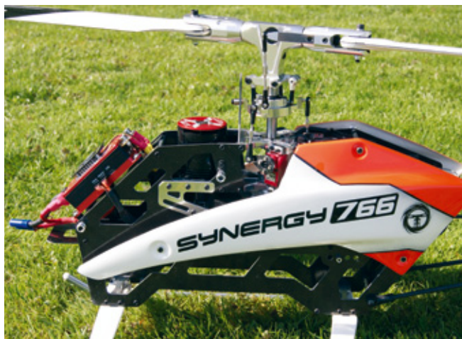
Mit demontierten Vorderteil der dreiteiligen Haube lässt sich der Akkuwechsel bequem vornehmen
