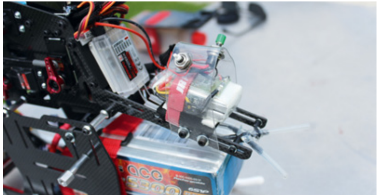
Clever gelöst: Der Stützakku vor dem Empfänger ist ein GensAce 2s-Lipo mit 800 Milliamperestunden Kapazität, der vom BEC über eine Elektronik von R 2 Prototyping geladen und balanciert wird. Die Ein-aus-Schalter sitzen später hinter den Lüftungs-Öffnungen des Staysee-Rumpfs und können dort gut erreicht werden
