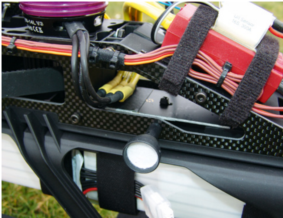
Deutlich zu erkennen – die im Haubenhalter eingeklebte Filzröhre, um die Magnetkraft zu entschärfen
