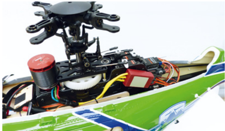
So gut ist die gesamte Mechanik zugänglich, wenn beide Hauben demontiert sind. Der Controller sitzt am Chassis
