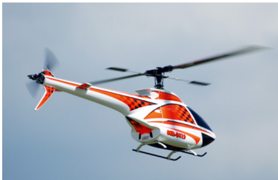
Stefans WM-Modell 2011 war seinerzeit noch gemäß FAI-Regelwerk-Vorschriften mit Stabilisierungsstange ausgerüstet
