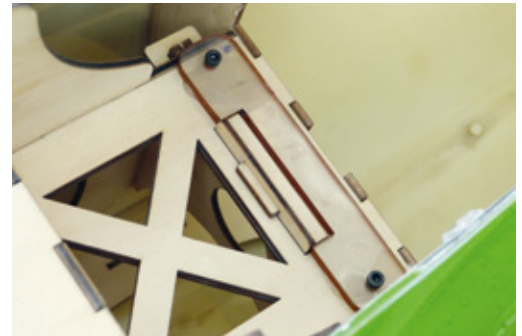
Um die Rotorwelle nach vorne zu neigen, sind die hinteren Mechanik-Befestigungspunkte mit Abstandsplatten versehen
