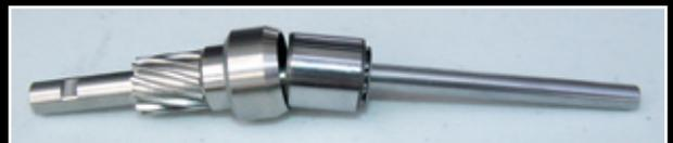
Die Motorwelle (rechts im Bild) wird ins Freilauflager gesteckt, das von einer Stahlhülse ummantelt wird. Die Einheit sitzt dann später in der Buchse der Ritzeleinheit
