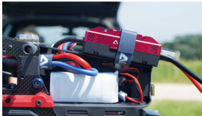
Der Align-Motor-Controller RCE 130 sitzt auf dem dafür vorgesehenen Platz im RC-Vorbau. Ein 2s-Buffer-Akku mit einer Kapazität von 800 Milliamperestunden sorgt für Sicherheit und unterstützt das BEC des Controllers
