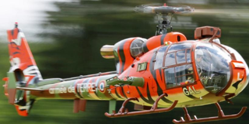
Der Gastgeber Bernd Pötting ließ es sich nicht nehmen, die brandneuen Gazelle von Heli-Factory zu fliegen. Das Modell hat einen Rotordurchmesser von 2,65 Meter, wiegt 24,9 Kilogramm und wird von einer Jakadofsky-Turbine Pro 6000 angetrieben
