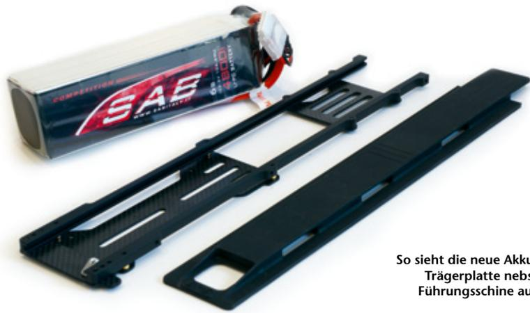
So sieht die neue Akku-Trägerplatte nebst Führungsschiene aus
