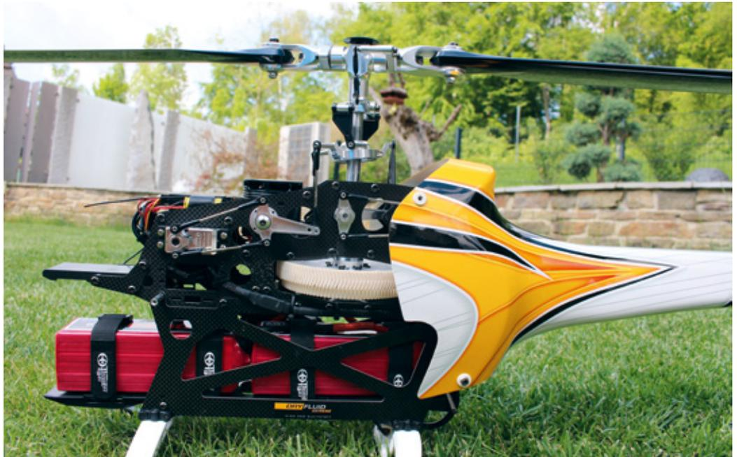
Die Heckverkleidung ist vorne an den Haubenhaltern befestigt und hinten mit einem Schaumstoff-Pass-Teil. Mit der Heckverkleidung müssen die kürzeren Heckstreben verbaut werden
