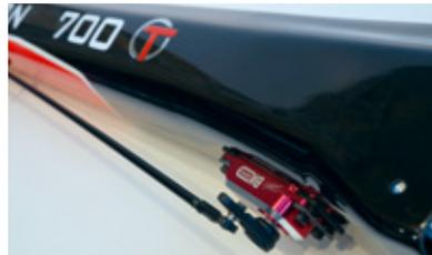
Das im unteren Bereich im Heckausleger eingelassene Servo. Die Anlenkung erfolgt über eine Kohlefaser-Schubstange
