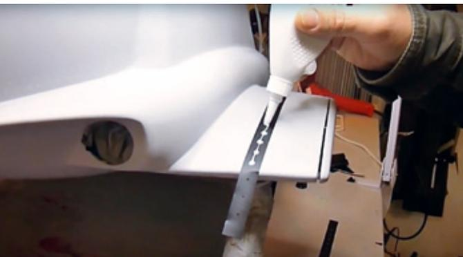
**Schritt 3: Gleichmäßig Weißleim in die Löcher einbringen – keinesfalls zu sparsam hantieren**
