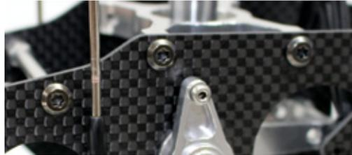
Deutlich zu erkennen – die im Text erwähnten Torxschrauben. Ein entsprechender Steckschlüssel gehört zum Lieferumfang
