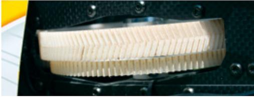
Das pfeilverzahnte Hauptzahnrad sowie das Heckabtriebszahnrad (Modul 1) werden mit Dryfluid Gear-Lube behandelt. Das Laufgeräusch ist sehr angenehm und das Getriebe ist sehr robust
