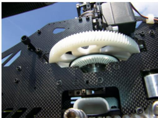
Das einstufige Getriebe besitzt ein schrägverzahntes Hauptzahnrad. Der Heckantrieb erfolgt über einen darunter befindlichen Tellerzahnkranz
