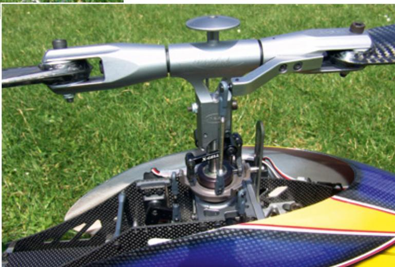
Das als Rechtsdreher ausgelegte Flybarless-Hauptrotorsystem des Whiplash mit Rotorkopf-Zentralstück und Blatthaltern aus Alu
