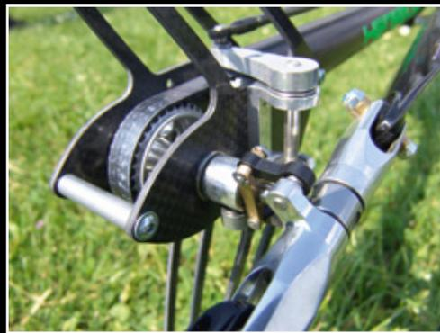
Der TDF-Heckrotor mit seinem großen, für die Reduzierung der Drehzahl notwendigen Riemenrad
