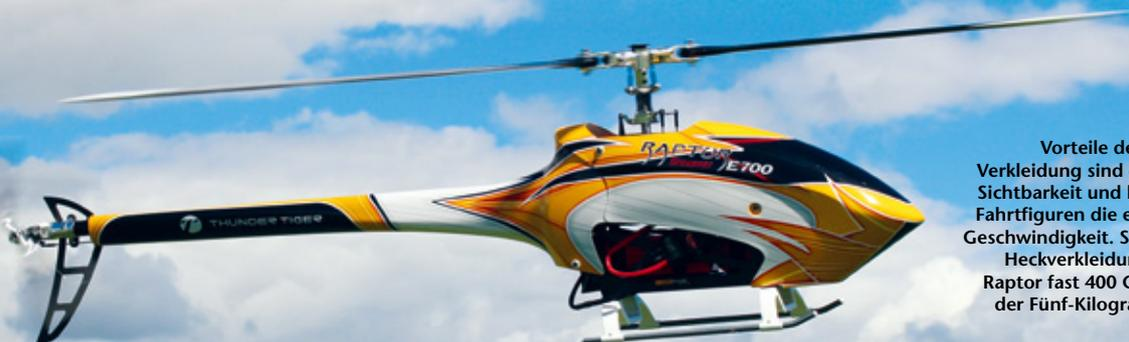
Vorteile der Vollrumpf-Verkleidung sind ganz klar die Sichtbarkeit und bei schnellen Fahrtfiguren die etwas höhere Geschwindigkeit. Selbst mit der Heckverkleidung bleibt der Raptor fast 400 Gramm unter der Fünf-Kilogramm-Grenze
