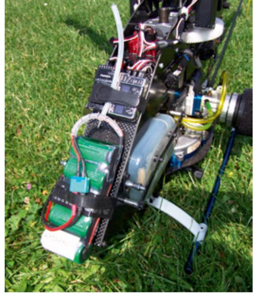
Für die Empfangsanlage nebst Flybarless-System und Versorgungsakku ist genügend Platz im Frontbereich des Chassis
