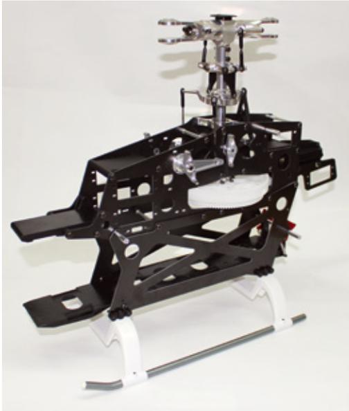
Das extrem leichte und stabile Chassis-Konstrukt mit montiertem Getriebe sowie Hauptrotormast
