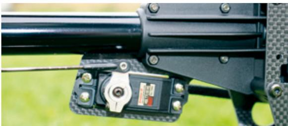
Das schnelle Heckrotorservo sitzt am Heckrohr und verfügt ebenfalls über einen justierbaren Servohebel
