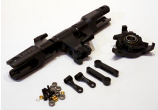
Das HPS-Hauptrotorsystem sowie die Taumelscheibe sind aus mattschwarzem Alu gefertigt. Die Mitnehmerarme sind SAB-typisch kugellagert
