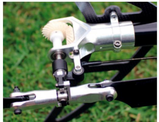
Aufgrund der Spiralverzahnung (Palloid) läuft der Heckrotor überaus leise und weich
