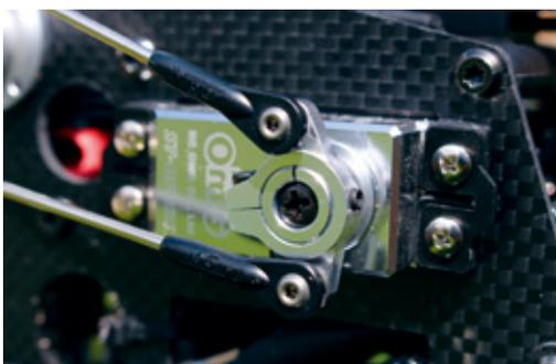
Detail des Servo-Abtriebs, bestehend aus einem inneren und einem äußeren Aluteil, um den eigentlichen Hebel bei Servo-Neutrallage entsprechend drehen zu können. Die Fixierung erfolgt über die seitliche Madenschraube
