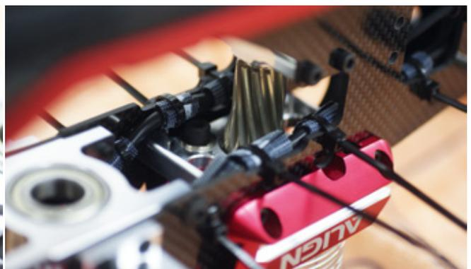
Die Kabel sind mit etwa 15 Millimeter langen Klettbändern umwickelt und werden mit Kabelbindern, die durch die Chassislöcher geführt sind, sicher in Position gehalten
