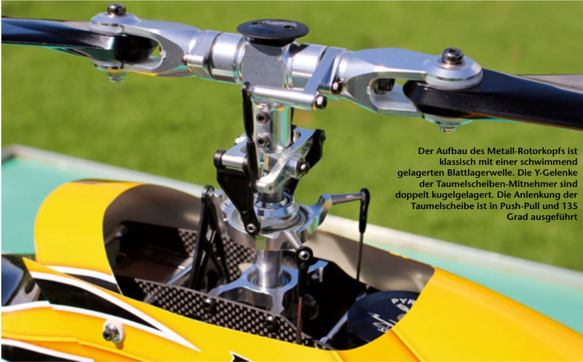
Der Aufbau des Metall-Rotorkopfs ist klassisch mit einer schwimmend gelagerten Blattlagerwelle. Die Y-Gelenke der Taumelscheiben-Mitnehmer sind doppelt kugelgelagert. Die Anlenkung der Taumelscheibe ist in Push-Pull und 135 Grad ausgeführt
