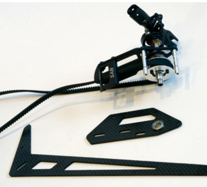
Das ist neu: Das Heckgetriebe hat sowohl ein Alu- als auch ein CFK-Seitenteil, Das Seitenleitwerk ist abnehmbar
