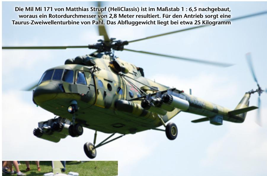
Die Mil Mi 171 von Matthias Strupf (HeliClassis) ist im Maßstab 1 : 6,5 nachgebaut, woraus ein Rotordurchmesser von 2,8 Meter resultiert. Für den Antrieb sorgt eine Taurus-Zweiwellenturbine von Pahl. Das Abfluggewicht liegt bei etwa 25 Kilogramm
