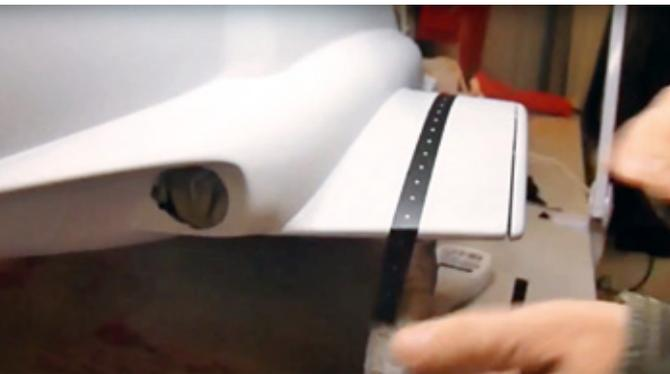
**Schritt 1: Nietenband an korrekter Position auf den gereinigten Rumpf aufbringen. Überstehendes Ende stehen lassen**
