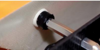
Beim Aufbau ohne Heckverkleidung müssen am oberen Haubenhalter Distanzen verbaut werden, damit das Hauptzahnrad nicht an der Haube streift
