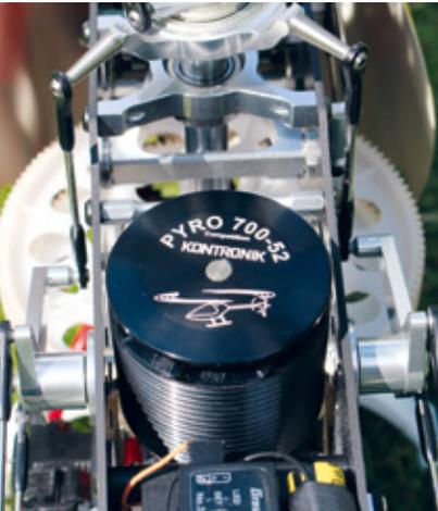
Der Kontronik Pyro 700-52 Competition passt perfekt zum E700 und ist auch effizienter als der Standard-Pyro. Einen größeren Motor kann man beim E700 aufgrund der Mechanikbreite nicht verbauen
