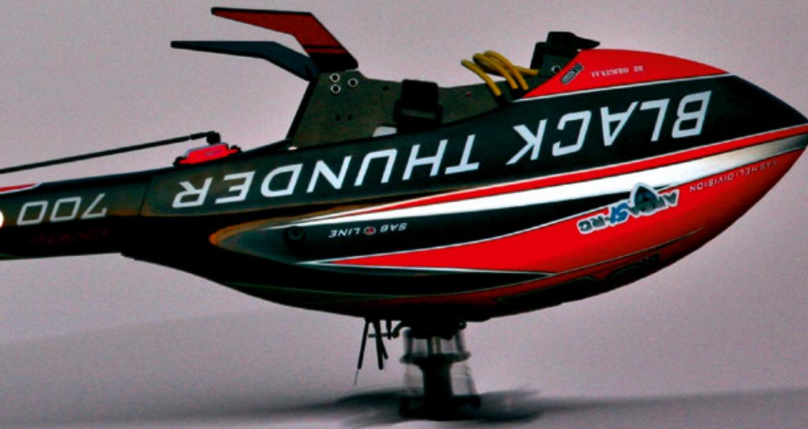
Um Gewicht zu sparen, verwendet SAB nur 1,5 Millimeter starke Kohlefaser-Chassisplatten
