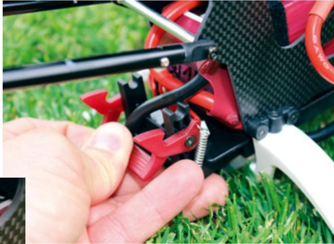
Die beiden 6s-LiPos werden auf der sehr leichten Kunststoff-Akkuschiene mit Klettbandern festgezogen. Die Einheit kann bei montierter Haube von hinten ins Chassis geschoben werden. Der Schnellverschluss wird hinten einfach eingerastet
