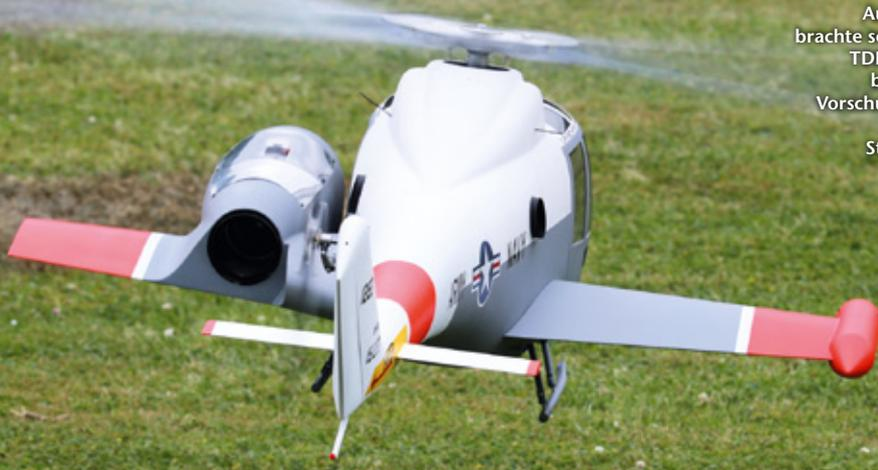
Die im Schweden-Outfit ausgeführte Lama SA 315B von Rene Gruhl mit einem Rotordurchmesser von 2,6 Meter und einem Gewicht von 24 Kilogramm. Deutlich zu erkennen ist die Zweiwellenturbine JetCat SPH 5, deren beiden Abgasrohre seitlich angeordnet sind
