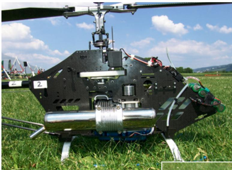
Blick auf die am Auslassstutzen montierte Edelstahl-Schalldämpfer-Einheit
