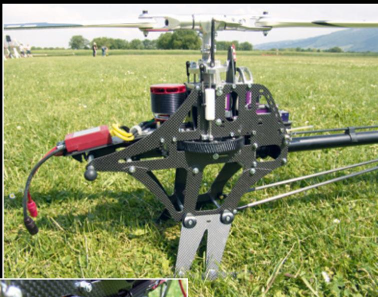
Das Chassis des TDF ist jetzt im unteren Bereich geteilt ausgeführt
