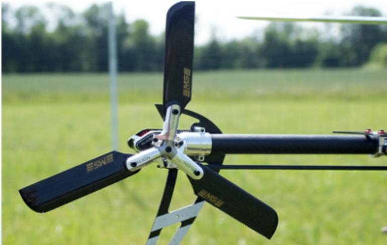
Zum Erhöhen der Heck-Performance wurde auf den optional erhältlichen Dreiblatt-Heckrotor umgerüstet (Standard beim brandneuen T-Rex 760). Bei den Heckrotorblättern kommen 106 Millimeter lange MS Composit zum Einsatz
