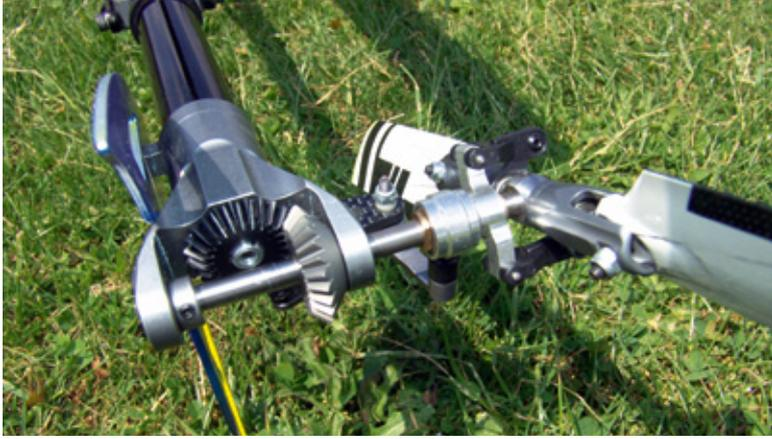
Das offene Heckgetriebe mit seinen beiden Kegelrädern und der klassischen Anlenkung über Umlenkhebel und Schiebehülse
