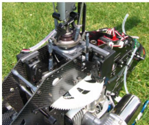
Bewährt hat sich die 120-Grad-Taumelscheiben-Anlenkung, wobei die Servos direkt am Chassis montiert sind
