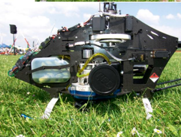
Der Aufbau des Chassis ist sehr stabil, aber dennoch sehr leicht gehalten. Frontseitig ist der Tank untergebracht, Benzinmotor nebst Seilzugstarter sind bestens zugänglich
