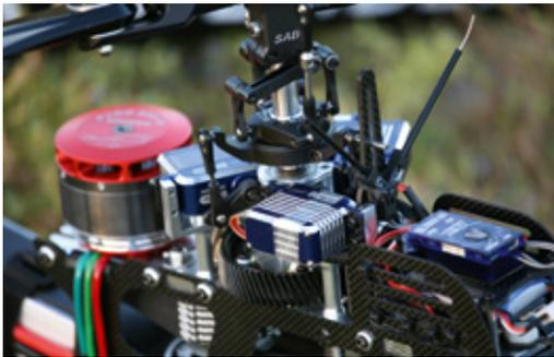
Die Anschlusskabel der drei Taumelscheiben-Servos sind mit Klebeband gesichert. Das VStabi NEO mit seinen beiden V-förmig angeordneten Antennen sitzt auf der dafür vorgesehenen Plattform
