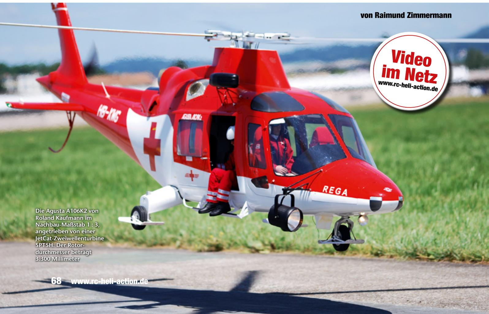
Die Agusta A106K2 von Roland Kaufmann im Nachbau-Maßstab 1 : 3, angetrieben von einer JetCat-Zweiwellenturbine SPT5H. Der Rotordurchmesser beträgt 3.300 Millimeter
