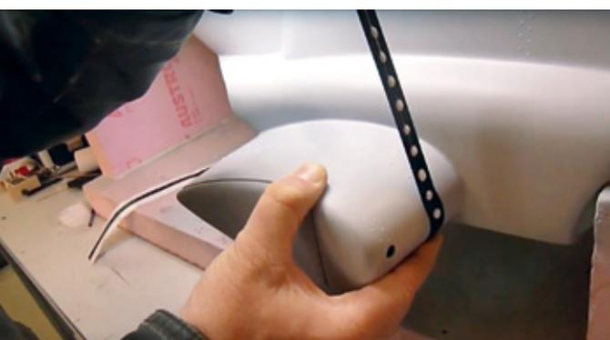
**Schritt 5: Band vollständig entfernen und Weißleim trocknen lassen**
