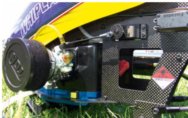
Auch bestens zugänglich sind Vergaser und Luftfilter. Das Gasservo ist im Chassis untergebracht
