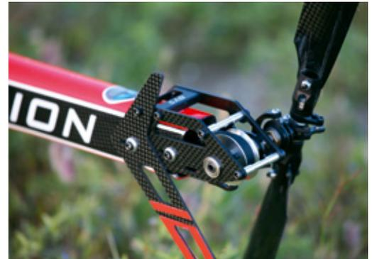
Montierte Einheit. So wird der Heckrotor am CFK-Heckausleger montiert, das Seitenleitwerk ist ein separates Bauteil (siehe Text), das an der linken CFK-Seitenplatte verschraubt wird
