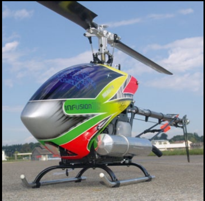
Der Heckrotor verfügt über leise laufende Kunststoff-Kegelräder, der Antrieb erfolgt über eine Starrwelle
