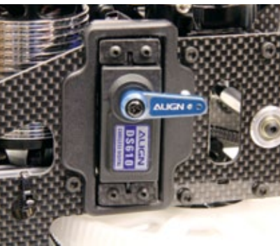
Eines der drei Taumelscheibenservos des Typs DS610, montiert im Servo-Aufnahmerahmen aus Kunststoff. Die Servohebel sind aus Aluminium
