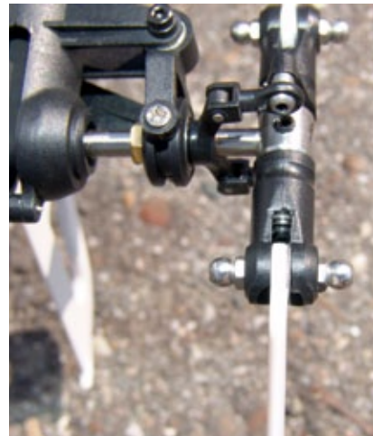
Die im Text erwähnten Propellermomentgewichte in Form von Kugelhöfen, die an den Blattbefestigungen angebracht sind
