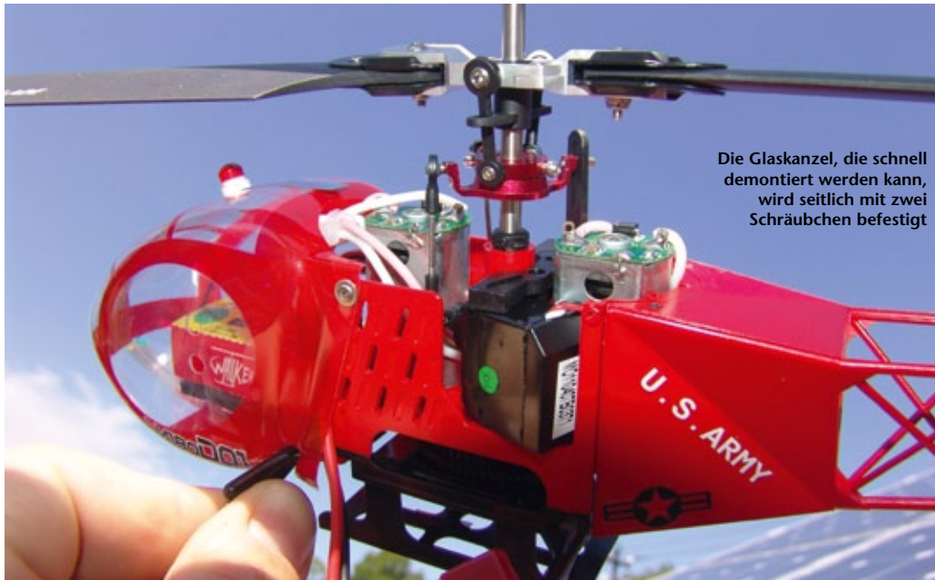
Für einen Koaxialhubschrauber sehr ungewöhnlich – ein Flybarless-System statt der üblicherweise am oberen Rotor verwendeten 45-Grad-Stabilisierungsstange
