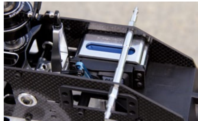
Das zwischen den Chassisplatten befestigte Nickservo sitzt in einem massiven Alurahmen. Der Nick-Anlenkhebel fungiert gleichzeitig als Taumelscheiben-Verdrehsicherung
