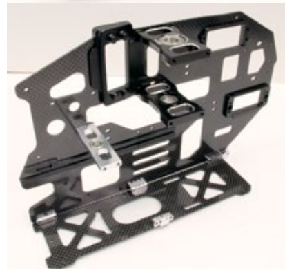
Schematischer Aufbau des Chassis. Deutlich zu erkennen ist die Schiene für die Akkuplatte
