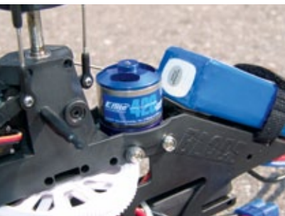
Optimale Größe, sowohl von den Abmessungen als auch von der Leistung – der Außenläufermotor E-Flite 420 3.800 kV, der während der Erprobung zu keiner Zeit übermäßig heiß wurde
