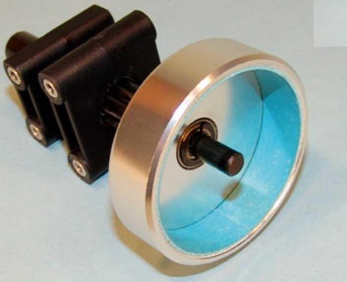
Der neue Kupplungsbelag ist eingesetzt. Man beachte den fast nicht mehr sichtbaren Stoß des Streifenmaterials im unteren Bereich der Glocke. So entsteht keine Stolperkante, aber ein perfekter Rundlauf
