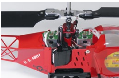
Blick auf die beiden Antriebsmotoren und den unteren Rotor mit seiner Metallnabe. Die Funktionen Nick und Roll werden über die beiden Servos realisiert, die über Gestänge mit der Metalltaumelscheibe verbunden sind
