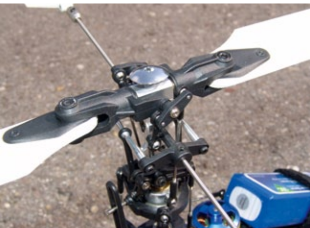
Das Zweiblatt-Hauptrotorsystem mit dem Aluminium-Zentralstück und der untenliegenden Hilfsrotoreinheit. Die einteiligen Blatthalter werden von hinten angelenkt, das heißt beim Positiv-Pitchgeben geht die Taumelscheibe abwärts und umgekehrt
