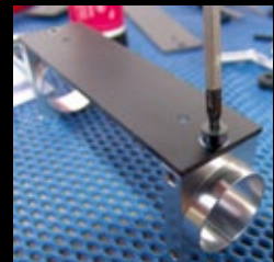
Alle Teile sind passgenau gefertigt. Hier die Alu-Heckrotoraufnahme, die mit einer Platte versteift wird und dadurch den definierten Abstand bekommt
