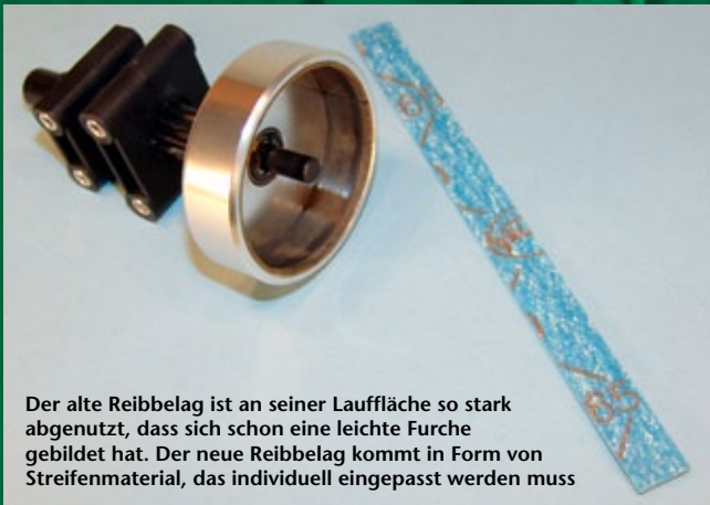
Die Kupplungsglocke wurde von ihrem alten Belag befreit und gesäubert. Der neue Kupplungsbelag wird sanft in eine Ringform gedrückt und passend abgelängt
