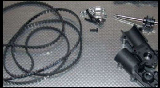
Einer der markanten Unterschiede des Lite gegenüber dem X5 in der Normalversion: Der Heckrotor wird über einen Zahnriemen angetrieben
