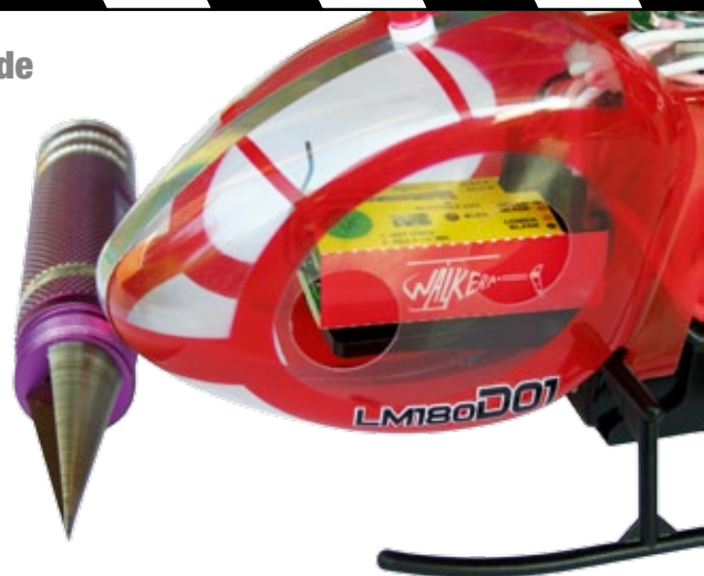
Die zusätzlich angebrachten Bohrungen im Glas können bei starker Sonneneinstrahlung die Sensoren vor einer Überhitzung (und eventuellen Drift) schützen
