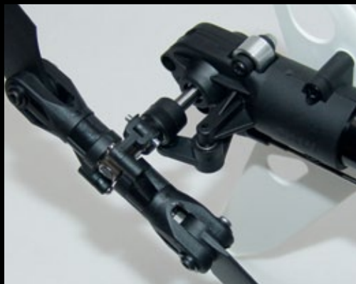
Ein Überspringen des Riemen verhindert eine kugelgelagerte Andruckrolle aus Aluminium
