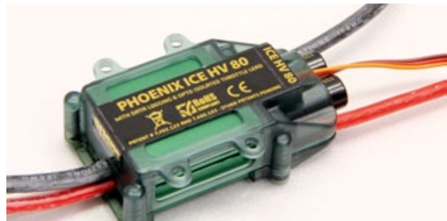
Der leistungsfähige Controller Castle Creation Phoenix ICE 80 HV V2 gehört zum Combo-Pack und wird im RC-Vorbau verstaut. Seine Regeleigenschaften (Governor-Modus) sind tadellos
