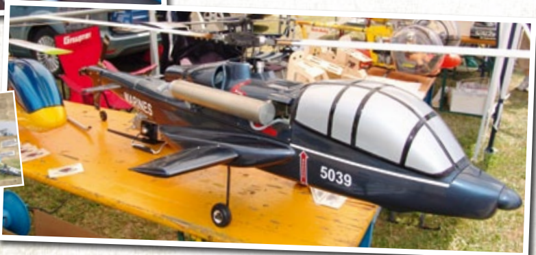
Die Schlüter Cheyenne basiert ebenfalls auf der Flachmechanik der SX81 und war mit dem Rotorkopfsystem des bewährten System 80 ausgestattet
