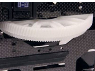
Das Hauptzahnrad ist schrägverzahnt und sorgt für angenehme Geräuschkulisse
