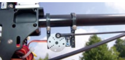
Am Heckrohr angeflanscht ist das schnelle Digitalservo des Typs E-Flite EFLRDS76T, das in Kombination mit dem verbauten Gyro-System und einem einwandfrei verarbeiteten Heckrotor für sehr gute Hochachsen-Performance sorgt
