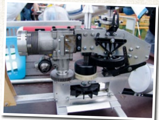
Ganz schön verwegend, die Schlüter Flachmechanik. Man beachte den langen Weg der Kühlluft, die nach oben dem Rotorstrahl entgegenwirken muss
