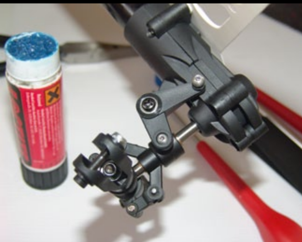
Die fertig montierte Einheit von unten: Hier sitzt der kugelgelagerte 90-Grad-Umlenkhebel. Deutlich zu erkennen auch die Anlenkung der Pitchbrücke
