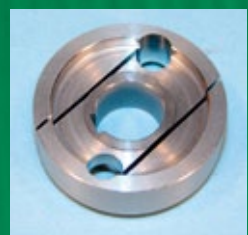
Beispiel eines Kupplungsläufers, der gegen die Motordrehrichtung öffnet. Die Backen bleiben nach dem Schlitzen über einen verbliebenen Steg elastisch angebunden und können (in gewissen Grenzen) nach außen federn
