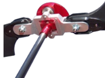
Unterhalb des roten Bremstellers befinden sich Gummipfättchen, mit denen das Rotorssystem gedämpft wird
