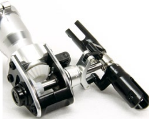
Bewährte und solide Technik findet man auch am Heckrotor. Die Kunststoff-Kegelräder halten höchsten Belastungen stand
