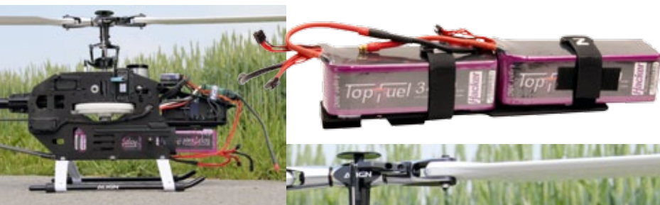
Die Seitenansichten verdeutlicht den konstruktiven Aufbau. Der Akkupack mit seiner Halteplatte lässt sich bequem im Schienensystem verriegeln
