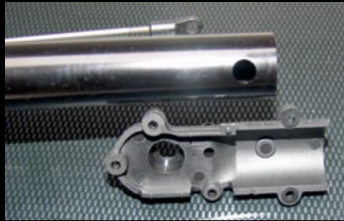
Die Gehäusehalbschalen des Heckrotors sind aus Kunststoff. Ein Verdrehen wird durch einen angespritzten Zapfen und die entsprechende Bohrung im Heckrohr verhindert
