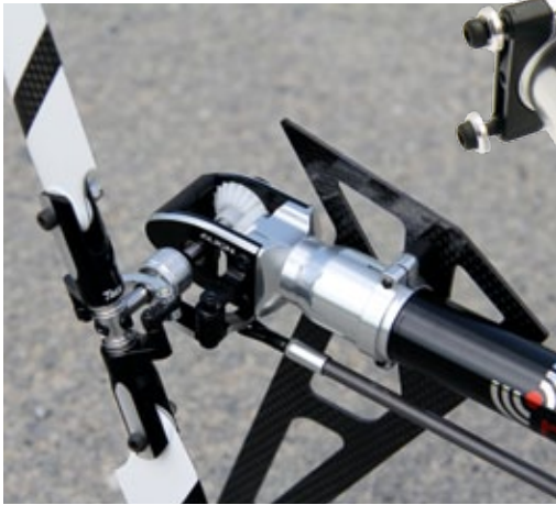
Bewährte und solide Technik findet man auch am Heckrotor. Die Kunststoff-Kegelräder halten höchsten Belastungen stand
