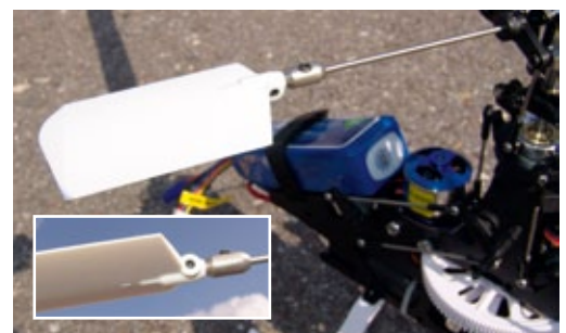
Die Steuerpaddel werden seitlich zusätzlich mit einer Madenschraube gesichert. Serienmäßig sind Zusatzgewichte montiert, die sich bei Bedarf noch weiter nach innen verschieben lassen, woraus zyklischere Agilität resultiert
