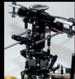
Wurde beim Lite kompromisslos vom X5 übernommen – der stabilisierte Zweiblattrotor aus Ganzmetall. Er ist robust, spielarm und sorgt für hervorragende Flugeigenschaften
