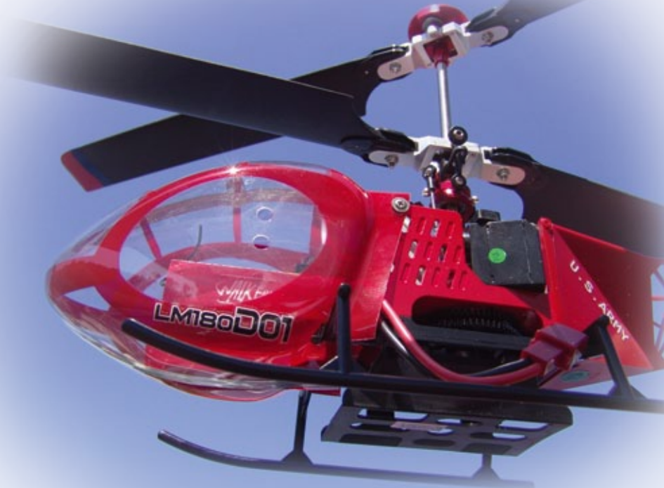
Walkera-typisch ist der unter dem Chassis befestigte Akkuschaft
