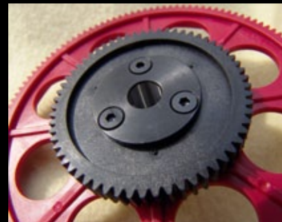
Das Zahnrad für den Heckrotorantrieb wird mit drei Senkkopfschrauben auf der Nabe befestigt. Darunter sitzt das Hauptzahnrad mit 120 Zähnen in einem Freilauf
