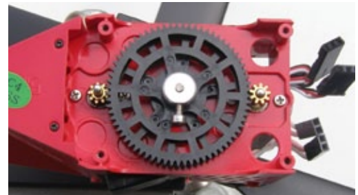
Blick auf das Getriebe mit den beiden gegenläufigen Hauptzahnradern und den Messinggritzeln
