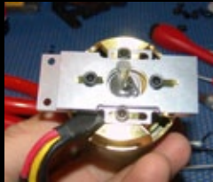
Der Stator des Motor wird mit dem Motorträger verbunden, in dem Langlöcher zur Getriebeispieljustage eingelassen sind
