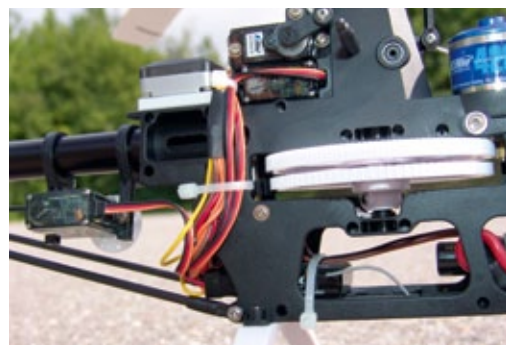
Die Hauptrotorwelle ist dreifach gelagert und verfügt somit über die so wichtige untere Abstützung, die Garant für ein sich während des Betriebs nicht änderndes Zahnflankenspiel ist. Der Spektrum-Empfänger AR6115E Microlite 6K liegt unten im Chassis, wobei sein Bind-Anschlusskontakt gut zugänglich ist
