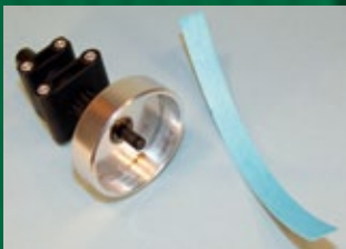
Die Kupplungsglocke wurde von ihrem alten Belag befreit und gesäubert. Der neue Kupplungsbelag wird sanft in eine Ringform gedrückt und passend abgelängt
