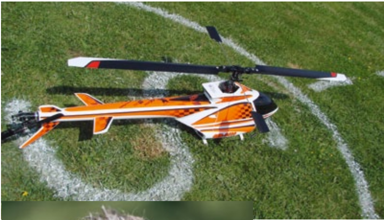
Auch Stefan Wachsmuth verwendet die Mechanik des JR Propo Sylphide E12, allerdings kombiniert mit dem Rumpf Dynamic von AKmod. Beim Antrieb setzt er auf Plettenbergs Copter 30-12 mit einem Schulze-future-Controller
