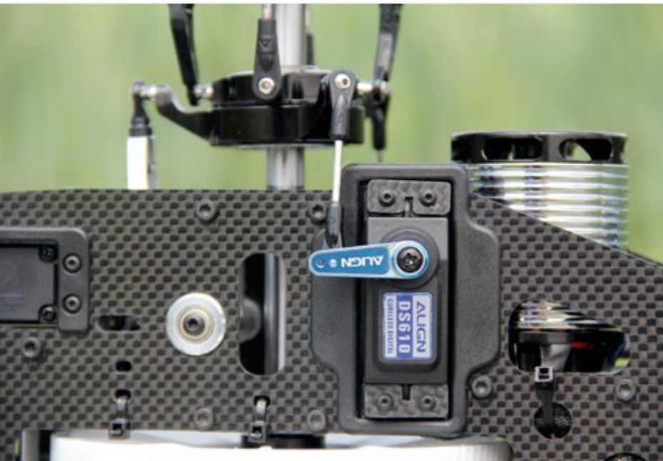
Die Gestänge der Taumelscheibenanlenkung fallen durch die hohe Position der Servos extrem kurz aus. Die Alu-Servohebel sorgen für die notwendige Steifheit der Anlenkung, was der Performance des Flybarless-Systems zugute kommt
