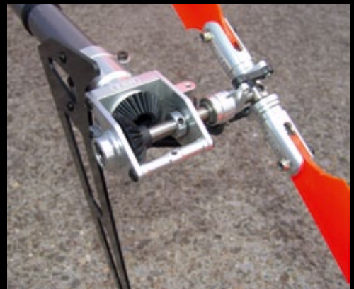
Der Heckrotor verfügt über leise laufende Kunststoff-Kegelräder, der Antrieb erfolgt über eine Starrwelle
