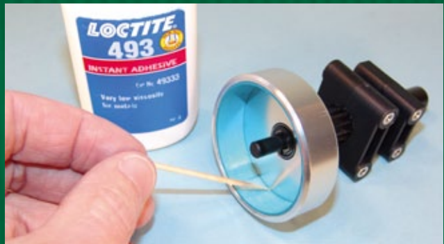
Mit Sekundenkleber wird der Belag in der Kupplungsglocke fixiert. Er ist dünnflüssig und kriecht so auch noch nachträglich durch die Kapillarwirkung in die kleinsten Ritzen
