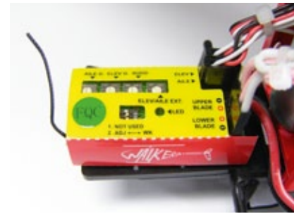
Für einen Koaxialhubschrauber sehr ungewöhnlich – ein Flybarless-System statt der üblicherweise am oberen Rotor verwendeten 45-Grad-Stabilisierungsstange
