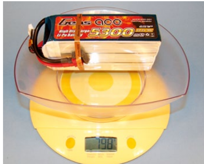
Der komplette 6s-LiPo mit einer Kapazität von 5.300 Milliamperestunden bringt 798 Gramm auf die Waage. Mit unseren 4-Millimeter-Steckverbindern landen wir bei 800 Gramm, der Werksangabe
