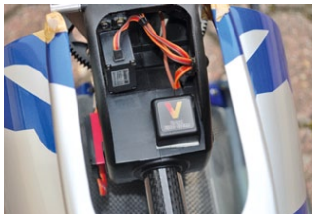
Der Sensor des Flybarless-Systems sitzt auf der Plattform über der Heckrohrlagerung
