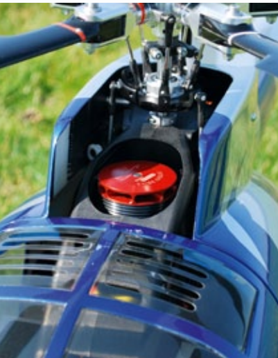
Der Pyro liegt beim Vorwärtsflug durch seine Montageposition optimal im Luftstrom
