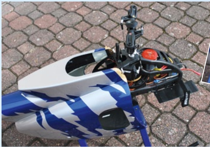
So wird die Mechanik in den Rumpf geschoben. Im Akkuschacht hat die Elektronik (Empfänger, V-Stabi, Jive, Jlog) Platz gefunden
