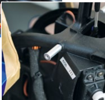
Blick auf den getunten Pyro-Motor und das im Modul 1 ausgeführte Getriebe. Deutlich zu erkennen ist auch der abgeklebte Rumpf im Bereich der oberen Mechanikbefestigung, um bei der Montage Kratzer im Lack zu vermeiden
