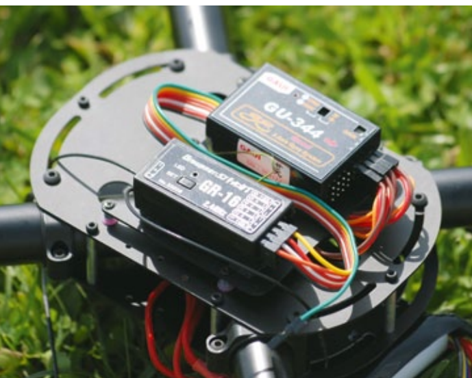
Die komplette Steuerung und Sensorik des Multikopters befindet sich in der GU-Box neben dem Empfänger
