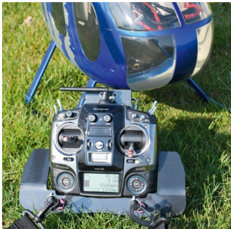
Die Telemetrie-Anzeige der Graupner mx-20. Für die Aufbereitung der Daten sorgt das im Modell verbaute Jlog, das seine Werte direkt aus dem Jive-Controller erhält
