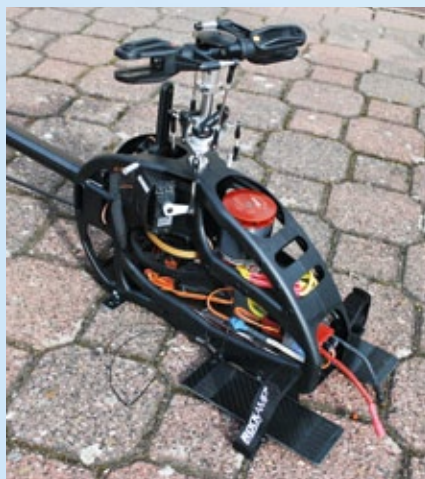
Die für den Einbau vorbereitete LOGO-600-Mechanik mit ihren seitlichen Plattformen für die Akkubefestigung
