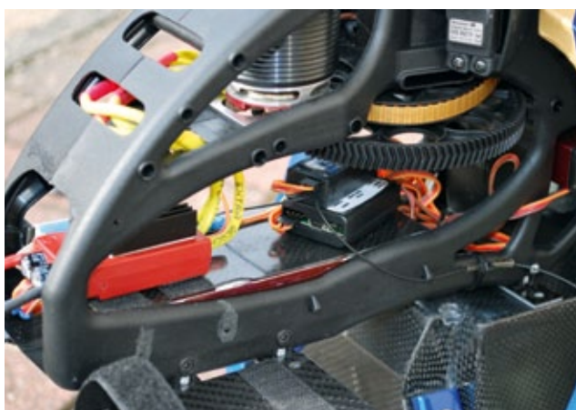
Die V-Stabi-Elektronik sitzt diagonal, um von vorne die Mini-USB-Buchse gut erreichen zu können
