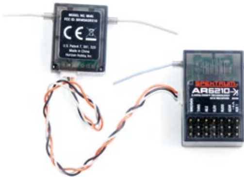
Empfänger mit vier Antennen, die alle in verschiedene Richtungen zeigen sollten, haben weniger Probleme mit falsch stehenden Antennen
