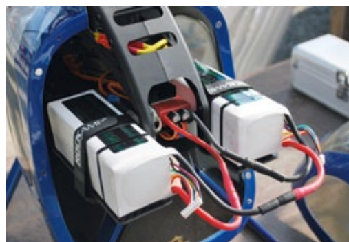
Die beiden 6s-Akku-Packs sind schwerpunktoptimiert platziert und lassen sich bequem von vorne wechseln. Die hinteren Fenster wurden deshalb verschlossen
