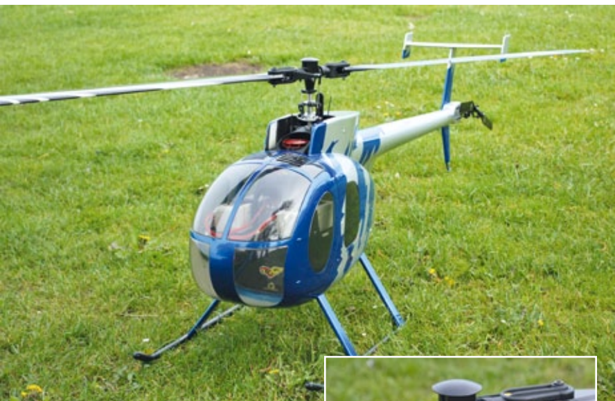
Mit dem Zweiblatt-Rigid-Rotorkopf von VARIO waren in Verbindung mit den Radix-Flybarless-Blättern sämtliche Vibrationen verschwunden (siehe Text)
