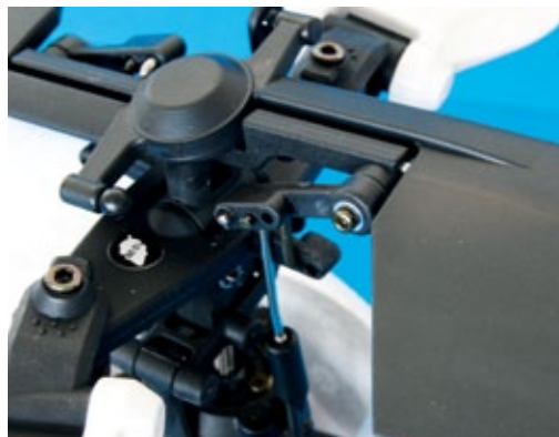
Für neutralere Flugeigenschaften sorgen die überarbeiteten Paddel. Diese sind vergrößert worden, haben jetzt zwei Anlenkpunkte und keinen positiven Einstellwinkel mehr
