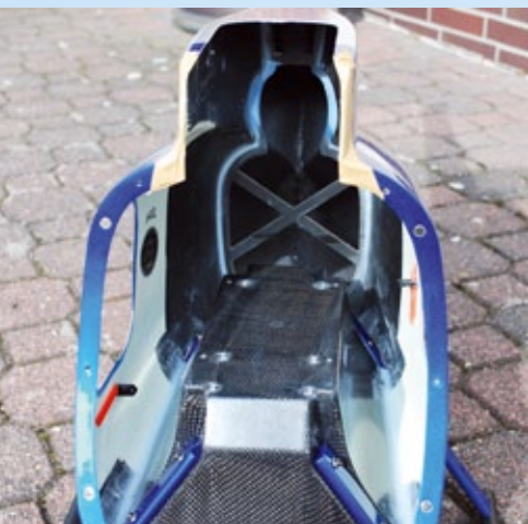
Kohlefaser bestimmt die Innenansicht. Mechanikpodest und Spanten zur strukturellen Festigkeit
