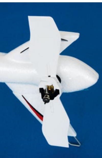
Die Heckrotorwelle ist wie bei der ersten Version des Funcopter kugelgelagert. Verbesserungen gibt es beim Heckrotor-Zentralstück: Dieses besteht nun nicht mehr aus Kunststoff, sondern beim V2 kommt eine Messingbuchse zum Einsatz
