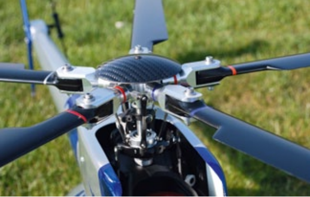
Der Benda-Fünfblatt-Hauptrotorkopf mit VARIO-Taumelscheibe und relativ gerader Anlenkung
