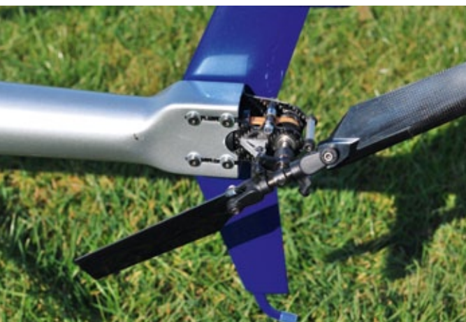
Heckrotor und Leitwerk werden gemeinsam befestigt. Das Leitwerk wird an der Heckrotor-Klemmung verschraubt
