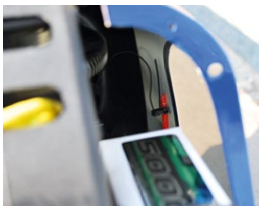
Die beiden Antennen des HoTT-Empfänger werden auf der Innenseite des Rumpfs rechts und links in Höhe der Fenster positioniert. Trotz des vielen Kohlefaser-Materials ergibt sich ein einwandfreier Empfang
