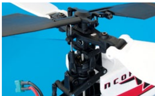
Der Rotorkopf des Funcopter ist solide aufgebaut. Das leichte Spiel in der Mechanik ist zu vernachlässigen, vor allem, da der Blattspurlauf dank Gewindestangen feinjustiert werden kann
