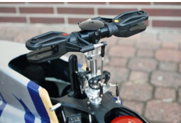
Der später für Kunstflug montierte Zweiblattkopf des LOGO 600 kam in Verbindung mit dem höheren Abfluggewicht (12s) mit seiner serienmäßigen Dämpfung ans Limit
