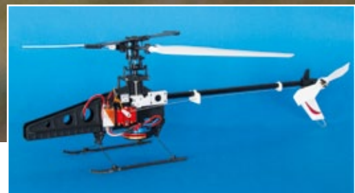
Die Elapor-Rumpfverkleidung lässt sich komplett abnehmen. Darunter kommt eine leichte Mechanik zum Vorschein
