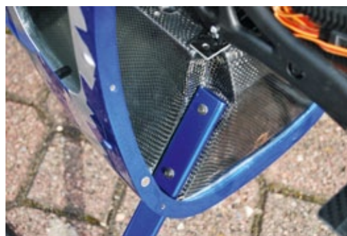
Am Mechanik-Podest sind die Kufenstreben verschraubt
