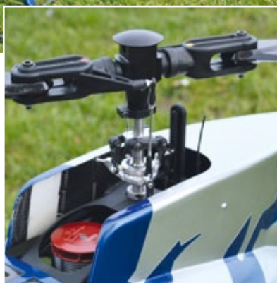
Mit dem Zweiblatt-Rigid-Rotorkopf von VARIO waren in Verbindung mit den Radix-Flybarless-Blättern sämtliche Vibrationen verschwunden (siehe Text)
