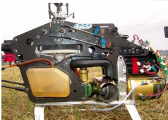
Zweiwellen-Turbine der Firma Wren aus England, hier in einem T-Rex 700 integriert. Ganz vorne am Lufteinlass befindet sich der Startermotor
