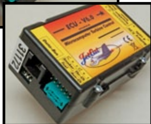
Die ECU, das Steuerorgan der Turbine, besitzt auf den beiden Stirnseiten insgesamt 13 Steckplätze
