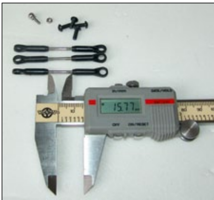
Die drei passend abgelängten Taumelscheiben-Gestänge müssen unbedingt gleichlang sein. Darauf achten, dass die frei sichtbaren Gewindegänge möglichst gleich lang sind
