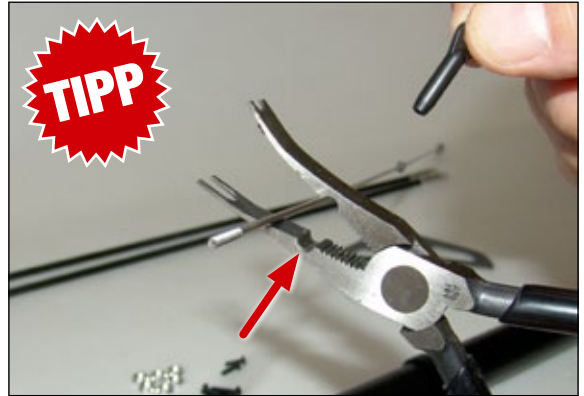
Um keine hässliche Zangenspuren auf dem Gestänge zu hinterlassen, empfiehlt sich der Einsatz von Kugelgelenk-Zangen, die mit halbrunden Aussparungen verschiedener Durchmesser versehen sind
