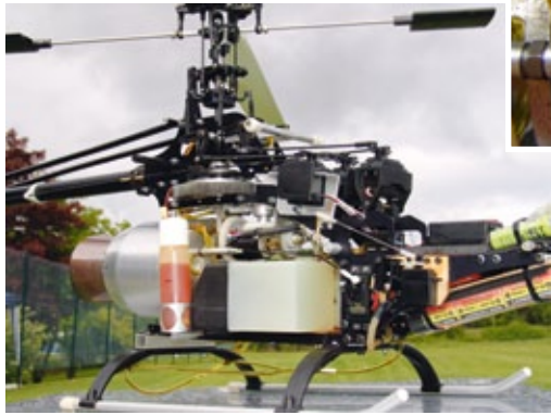
Einer der ersten Eigenbau-Helis mit Wellenturbine – der Futura von Raimund Kreher aus Darmstadt
