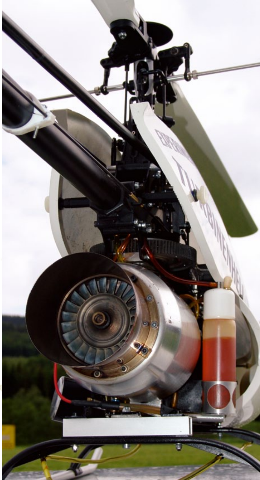
Eine über zehn Jahre alte Mechanikstudie der Firma JetCat, ein Vorläufer der danach in Serie gegangenen PHT3
