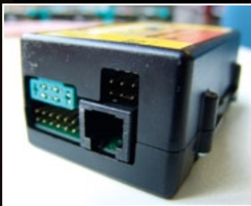
Aufgrund der vielen Sensoren und Steuerorgane befinden sich auf den beiden Stirnseiten der ECU insgesamt 13 Steckplätze
