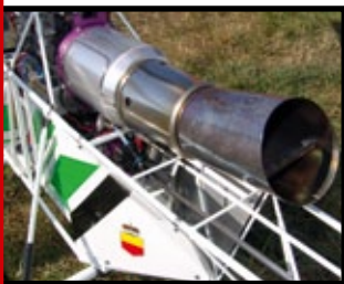
Der aufgesetzte Abgasrohr-Diffusor aus 0,3 Millimeter starkem Edelstahlblech
