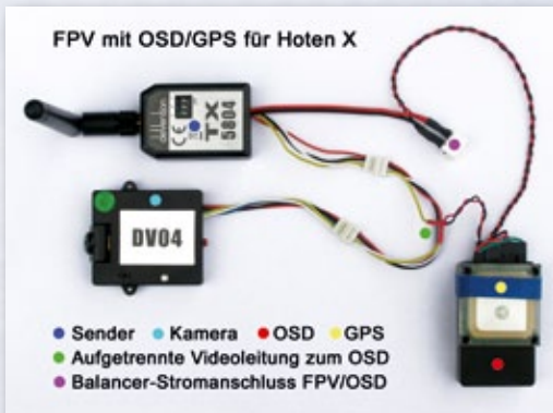
Verkabelung von FPV/OSD/GPS für Hoten X. Die DV04 unbedingt durch die CM210 ersetzen
