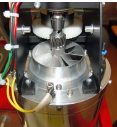
Blick auf die am Lufteinlass mit schrägverzahntem Ritzel versehene Turbinenwelle einer Pahl-Turbine, die ebenfalls auf Zahnradgetriebe setzt
