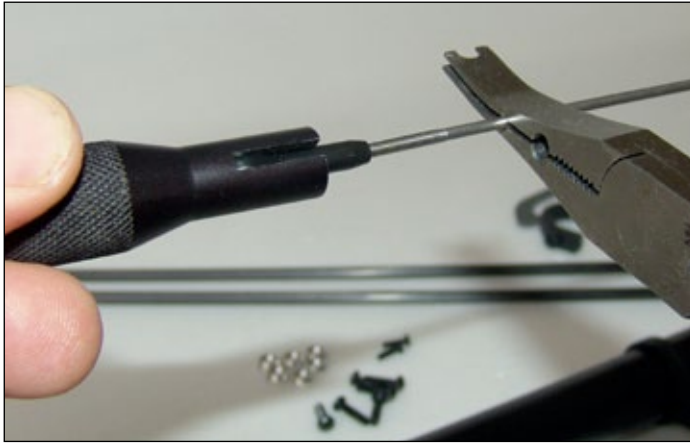
Gegebenenfalls ist es notwendig, beim Aufdrehen der Gelenke das Gestänge mit einer Zange zu fixieren. Hier das lange 2-mm-Heckrotorgestänge
