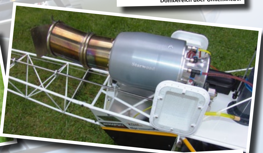
Optimiert ist die Lama für den Einsatz einer Jakadofsky-Turbine, hier vorzugsweise in der entsprechend angebotenen Starwood-Edition. Das Abgasrohr und der Scale-Tank unter der Rotorwelle gehören mit zum Bausatz
