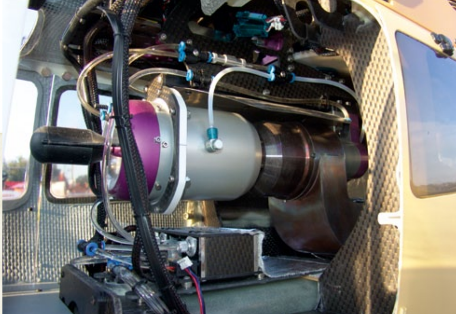
Ob hängend, liegend, stehend, vorne oder hinten – auch eine Welleleistungs-Turbine lässt sich in Kombination mit der entsprechenden Mechanik an beinahe jedes Heli-System anpassen
