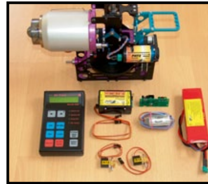
Lieferumfang der JetCat PHT2-Turbinenmechanik, bei der sämtliches Peripherie-Equipment zum Set gehört. Ganz links die GSU
