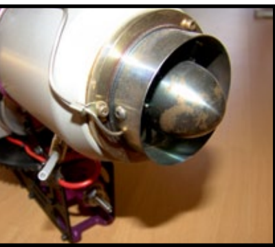
Am Auslass sitzt der Temperaturfühler. Er liefert der ECU die Werte der aktuellen Abgastemperatur
