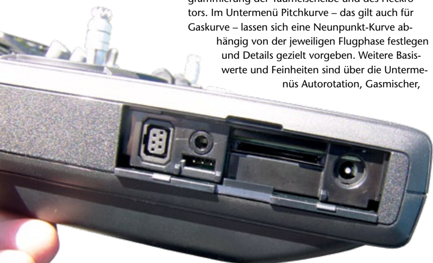
In der linken Seitenwand befinden sich die vor Schmutz geschützten, hinter einer Klappe versteckten Anschlussbuchsen für S.BUS, zum Laden sowie für Diagnose-beziehungsweise Lehrer-Schüler-Betrieb und der Slot für die Speicherkarte
