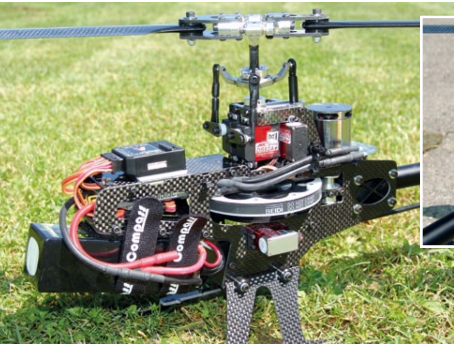
Der Drehzahl-Controller sitzt direkt unter dem Flybarless-System. Die drei Kabel zum Motor verlassen das Chassis seitlich und laufen nach hinten. Das Heckrotorservo liegt unter dem Riemenrad
