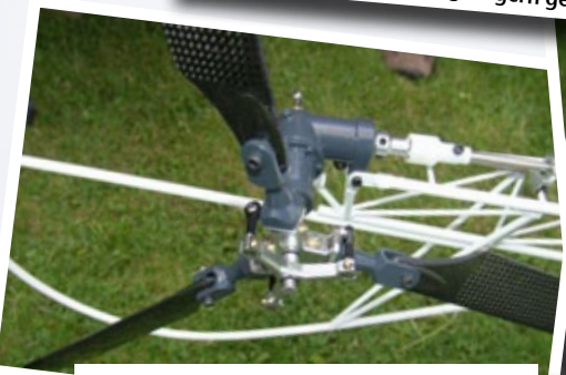
Auch der Dreiblatt-Heckrotor ist sehr detailgetreu nachgebildet. Die Pitchbrücke wird über ein in der hohlen Heckwelle befindliches Steuergestänge angelenkt
