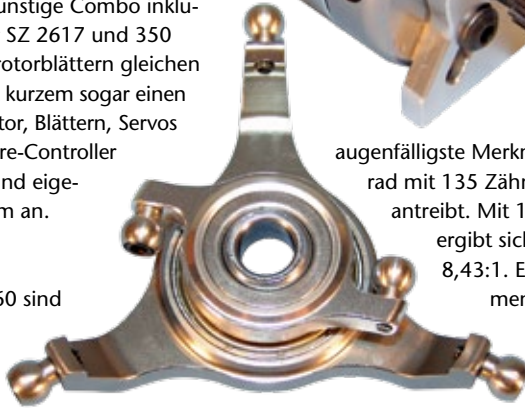
Die Metall Taumelscheibe repräsentiert sehr gut die Fertigungsqualität des Baukastens
