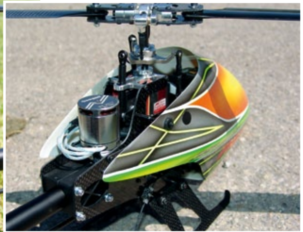
Der hinter der Rotorwelle frei in der Mechanik stehende Motor wird optimal gekühlt. Hier erkennt man auch den zusätzlichen Aufhängepunkt der Kabinenhaube, um sie weiter vorne montieren zu können
