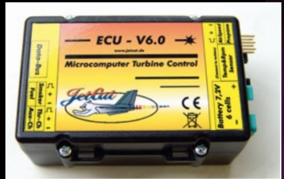
Die ECU (Engine Control Unit) übernimmt das komplette Turbinen-Management. Hier fließen alle Daten zusammen und werden alle Befehle generiert
