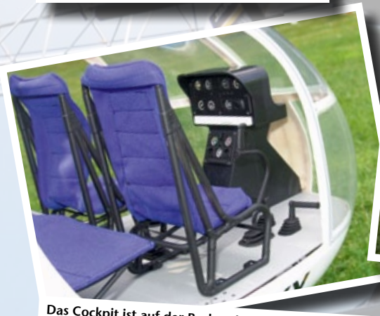
Das Cockpit ist auf der Bodenplatte montiert und lässt sich leicht herausnehmen. Sämtliche Elektronik inklusive der Taumelscheibenservos ist im Rumpfbaucah verstaut
