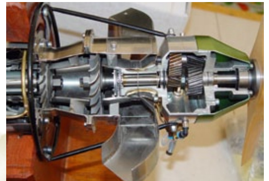
Das Schnittmodell der Turboprop-Version (weitestgehend identisch mit Heli) verdeutlicht den Aufbau der Wren-Zweiwellenturbine
