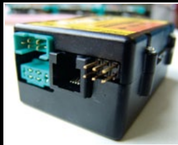
Aufgrund der vielen Sensoren und Steuerorgane befinden sich auf den beiden Stirnseiten der ECU insgesamt 13 Steckplätze
