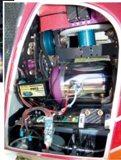
Die PHT3 der Firma JetCat ist die weltweit erste in Serie produzierte Modellhubschrauber-Turbine. Markant ist das zweistufige Zahnriemengetriebe in der Primärstufe. In der Sekundärstufe arbeitet eine robuste Kegelrad/Zahnrad-Kombination
