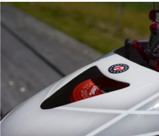
Genügend Frischluftzufuhr für den Pyro wird über eine entsprechende Haubenaussparung garantiert
