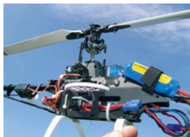
Zum Vergleich der Blade 300 X mit Kunststoff-Chassis, Kunststoff-Hauptrotor, liegenden Roll-Servos, oben angeordneter Motor und im Chassis verstauten AR7200BX
