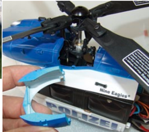
Die Domhaube lässt sich ebenfalls abnehmen und gibt den Zugang zum Rotormast frei
