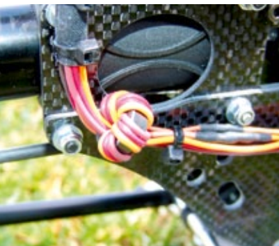
Da über das BEC eine galvanische Verbindung zwischen Controller und Empfänger besteht, wird ein Ferritkern (Lieferumfang) zum Dämpfen von eventuell über die Zuleitung eingeschleppter Störungen verwendet
