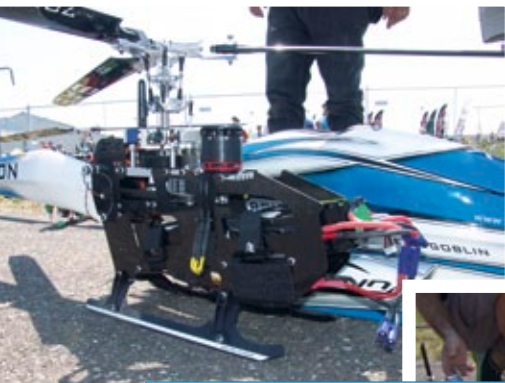
Auf Basis des Goblin 770 entstand bei SAB eine reinrassige F3C-Mechanik mit zweistufigen Getriebe. Der SAB Urukay kommt mit langgezogener Haube und Mono Boom-Heckausleger, hier in Dreiblatt-Ausführung
