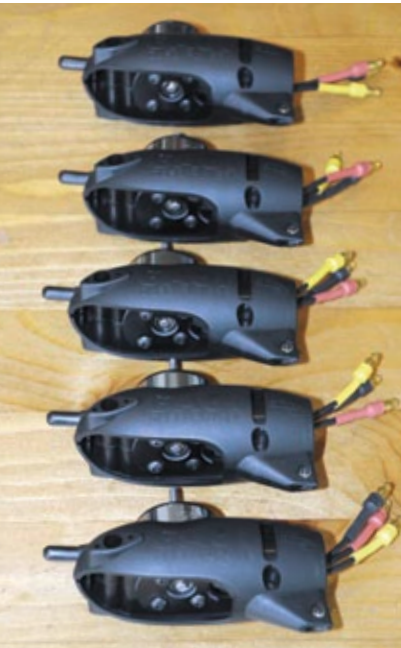
Serienfertigung – fünf der fertig montierten Motorgondeln
