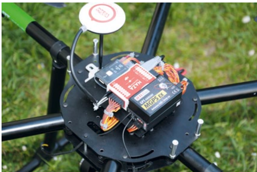
Das Naza M Lite sitzt exakt mittig auf der Platine, daneben der Jeti-Empfänger, GPS-Sensor und V-Sens. Die Naza-GPS-Antenne befindet sich in einem gesonderten Halter, um nicht von der Elektronik beeinflusst zu werden
