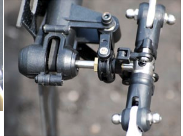
Der Heckrotor des Blade 300 CFX ist identisch mit dem des 300 X. Markant sind die an den Blatthaltern befestigten Propellermomentgewichte
