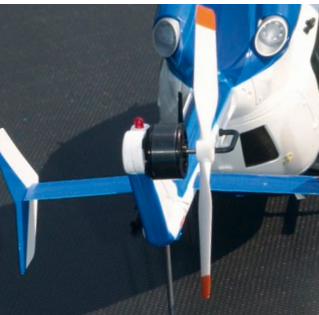
Am hochgesetzten Heck arbeitet ein bürstenloser Außenläufer in Verbindung mit einer Zweiblatt-Luftschaube
