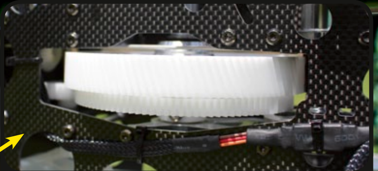
Das schrägverzahnte Hauptzahnrad mit integriertem Freilaufgerät, darunter das Zahnrad für den Heckrotor-Abtrieb
