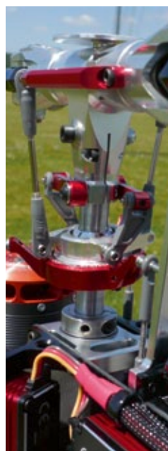
Die Rotorwelle wird mittels Klemmring über dem oberen Alu-Domlager axial gesichert
