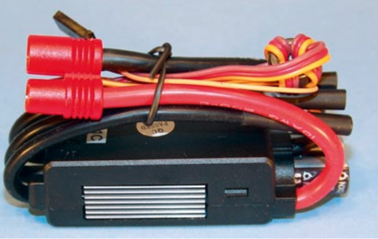
Alle Graupner-Controller brushless control +T HV kommen fertig konfektioniert mit angelöteten Steckverbindern
