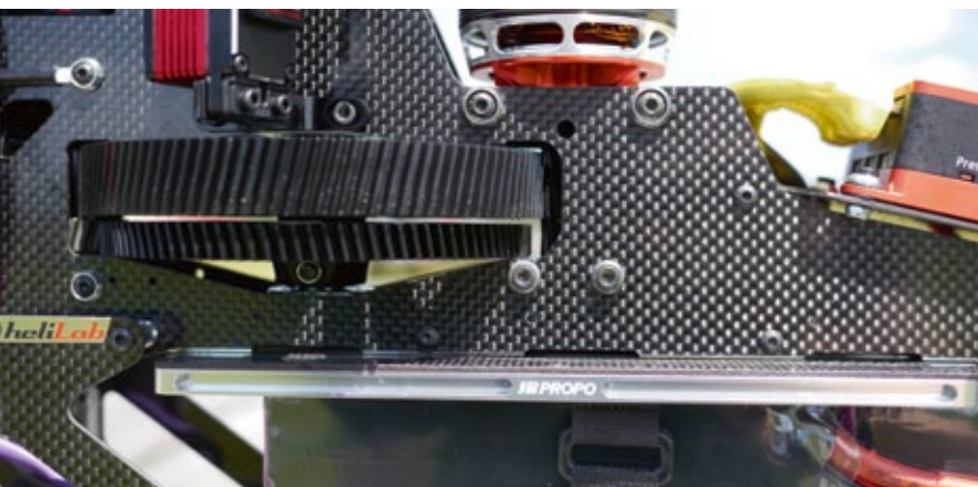
Das schrägverzahnte Hauptzahnrad, darunter das Zahnrad für den Heckabtrieb
