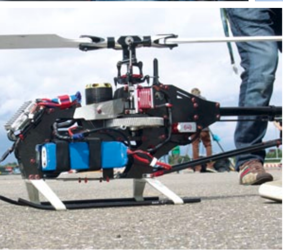
Duncan Bossion setzte den Gaii X7 mit folgenden Komponenten ein: Motor Scorpion HK 4525-520, Controller Scorpion, MKS-Servos, microbeast Flybarless-System, SpinBlades-Hauptrotorblätter mit 685 mm Länge, Heckblätter SpinBlades 105 mm, LiPo-Akku Optipower und Sender Futaba 18MZ. Duncan gewann auch in diesem Jahr souverän den 3D-Cup, der größte RC-Heli-Wettbewerb in Frankreich, der vom Jurassic-Rotor-Team nach dem Format des Heli Masters veranstaltet wurde
