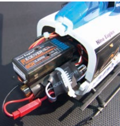
Der NineEagles Sechskanal-Empfänger besitzt ein integriertes Flybarless-System und lässt sich mit jedem S-FHSS-Sender binden. Rechts im Bild der Controller für den Heckmotor, unter dem Receiver der Controller für den Hauptmotor
