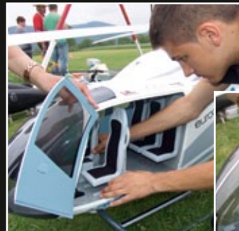
Einfacher Akkuwechsel: Beide linken Seitentüren öffnen, ...
