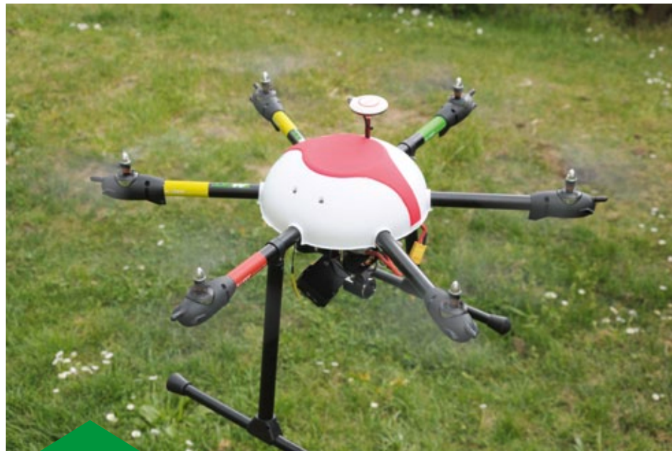
Hier der MRT 540 mit montierter Abdeckung. Zur Lageerkennung dienen die Farbmarkierungen auf den Auslegerarmen
