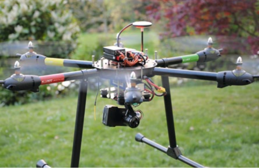
Dank der bewährten Naza M-Flight Control liegt der Hexakopter brettstabil in der Luft. Das Kamera-Gimbal ist bereits montiert
