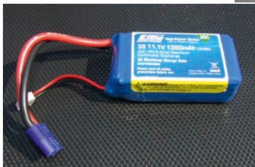
Der noch zu besorgende 3s-LiPo wird auf der Alu-Konsole festgezurt
