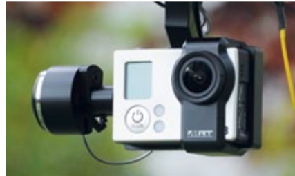
Das MRT Zweiachs-Gimbal Crane H3 mit der montierten GoPro 3 sorgt für wackelfreie Aufnahmen
