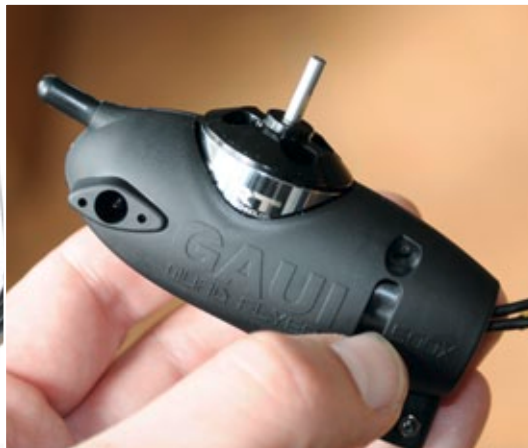
Die Gaiu BL-Motoren werden in entsprechenden Kunststoff-Gondeln montiert
