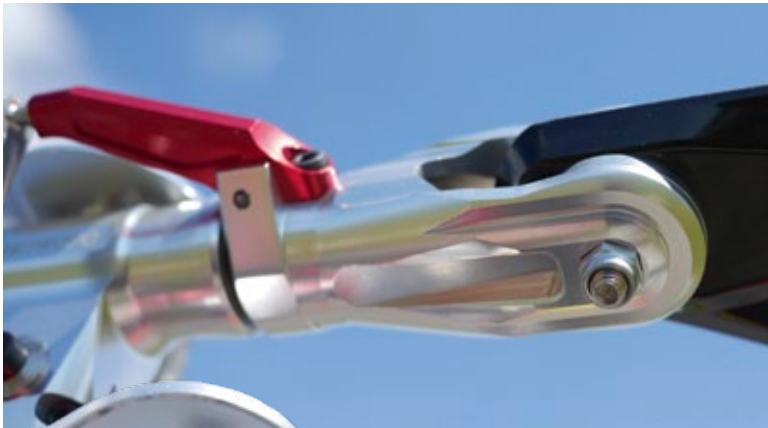
Die Stoppmuttern der Blattbefestigung werden durch entsprechende Blatthalter-Ausfräsungen am Mitdrehen gehindert
