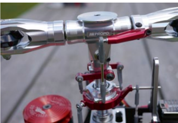
Die Rotorwelle wird mittels Klemmring über dem oberen Alu-Domlager axial gesichert
