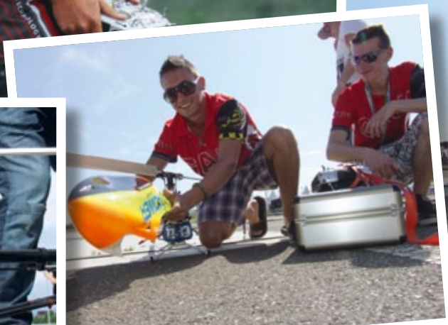
Duncan Bossion setzte den Gaii X7 mit folgenden Komponenten ein: Motor Scorpion HK 4525-520, Controller Scorpion, MKS-Servos, microbeast Flybarless-System, SpinBlades-Hauptrotorblätter mit 685 mm Länge, Heckblätter SpinBlades 105 mm, LiPo-Akku Optipower und Sender Futaba 18MZ. Duncan gewann auch in diesem Jahr souverän den 3D-Cup, der größte RC-Heli-Wettbewerb in Frankreich, der vom Jurassic-Rotor-Team nach dem Format des Heli Masters veranstaltet wurde
