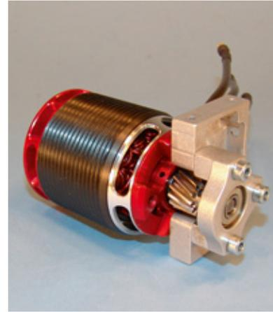
Ein Gegenlager fängt das auf die Motorwelle vom Ritzel kommende Biegemoment ab und entlastet so das vordere Lager im Motor zusätzlich
