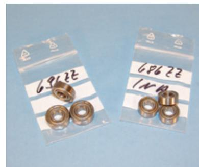
Typische Austausch-Kugellagersätze für bürstenlose Außenläufer, hier für einen Pyro 700
