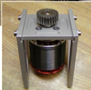
Die Motorplatte gleitet saugend in der Nut der Haltewinkel
