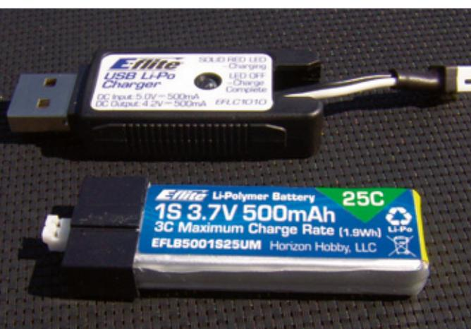
Zur Stromversorgung dient ein 1s-LiPo, geladen wird über USB mittels des Chargers
