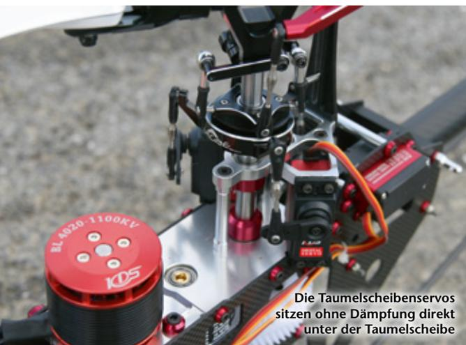
Die Taumelscheibenservos sitzen ohne Dämpfung direkt unter der Taumelscheibe
