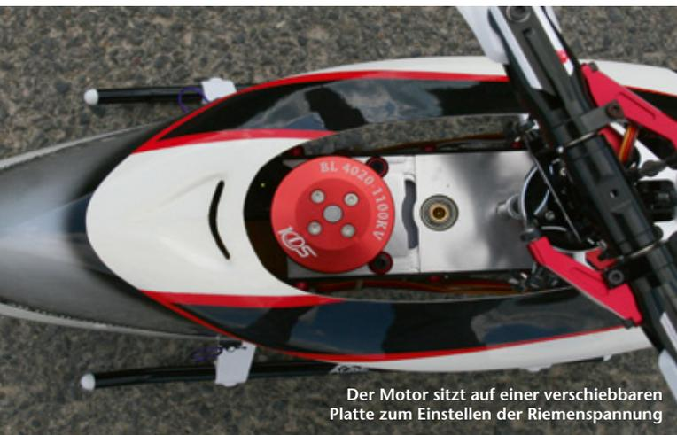
Der Motor sitzt auf einer verschiebbaren Platte zum Einstellen der Riemenspannung
