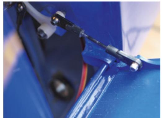
Die im Text beschriebenen Kunststoff-Klötzchen, in das auf der Klappe verklebte Kohlerohr gelagert wird
