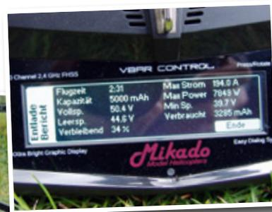
... auf eine Leistungsaufnahme von 7.849 Watt bei 194 Ampere Spitzenstrom
