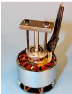
Ist die Achse der Magnetglocke in den Kugellagern festkorrodiert, leistet eine selbstgebaute Abziehvorgang gute Dienste, um sie wieder lösen zu können
