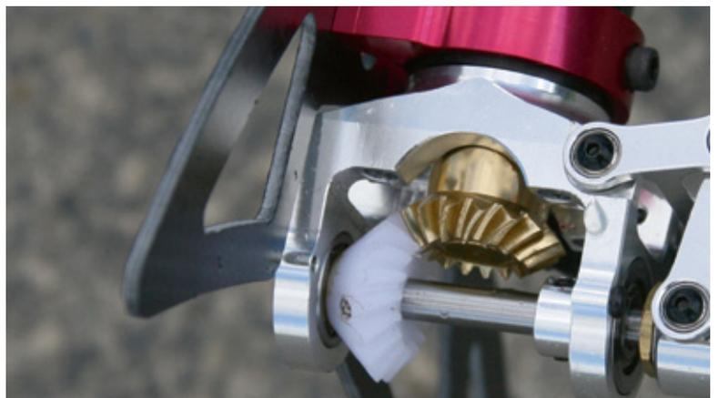
Das Heckgetriebe besteht aus kreisbogenverzahnten Kegelrädern, gefertigt aus Delrin und Messing: perfekte Materialpaarung und sehr leise im Betrieb
