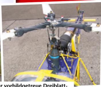
Der vorbildgetreue Dreiblatt-Hauptrotor der Lama von René Bühler hat einen Durchmesser von 2.500 Millimeter
