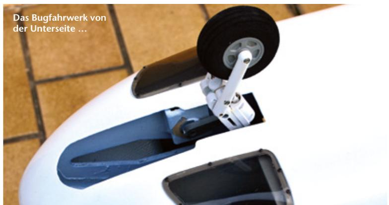
Das Bugfahrwerk von der Unterseite ...
