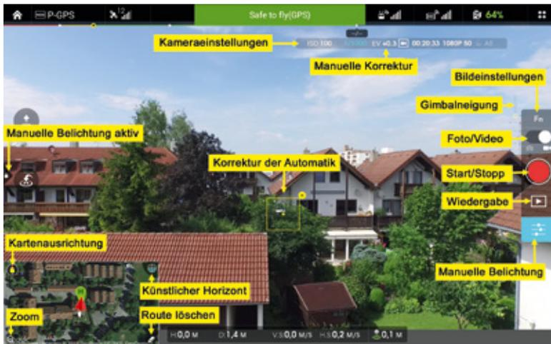
Die Bildseite zeigt das digitale Video-Downlink – hier beim Professional – mit hoher Bildqualität und ermöglicht Steuerung und Einstellung der Kamera. Antippen des kleinen Bilds unten links maximiert die Kartenseite
