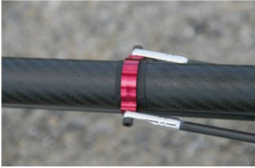
Die Schelle der Heckabstrebung ist auf einem Schrumpfschlauch gelagert, um das empfindliche CFK während des Betriebs nicht abzuwetzen
