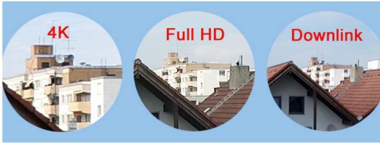
DJI-Bildqualität anhand winziger Ausschnitte im Vergleich. Die „gefühlte Schärfe“ ist in allen Ausschnitten fast gleich, das volle 4K-Bild hat jedoch die vierfache Fläche des HD-Bilds und das HD-Bild wiederum die doppelte Fläche des Professional-Downlinks. Das HD-Bild zeigt dank Pixeladdition im Gegensatz zum 4K-Bild kein Rauschen (körniger Himmel).
