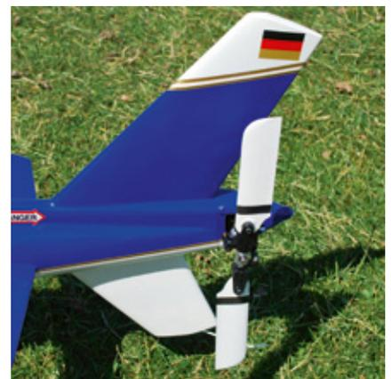
Das Höhenleitwerk besteht aus ABS-Kunststoff-Halbschalen. Der Graupner Tuning-Heckrotor hat eine Pendelnahe und eine doppelte Anlenkung
