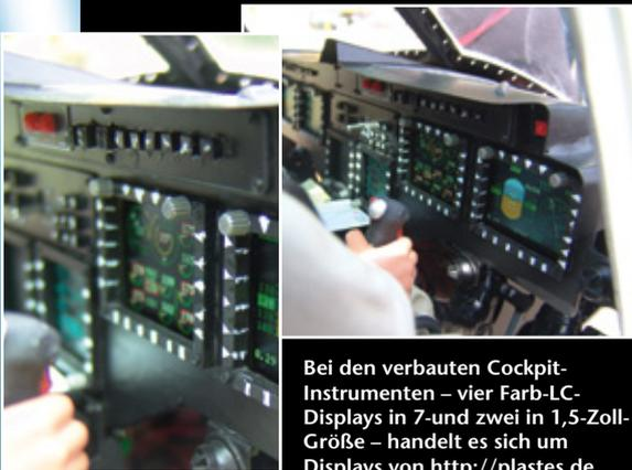
Bei den verbauten Cockpit-Instrumenten – vier Farb-LC-Displays in 7- und zwei in 1,5-Zoll-Größe – handelt es sich um Displays von <http://plastes.de>
