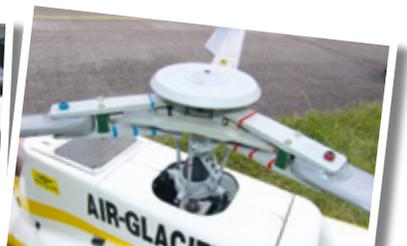
Der vorbildgetreue Starflex-Dreiblatt-Hauptrotor hat einen Durchmesser von 2.200 Millimeter
