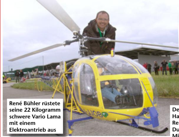
René Bühler rüstete seine 22 Kilogramm schwere Vario Lama mit einem Elektroantrieb aus
