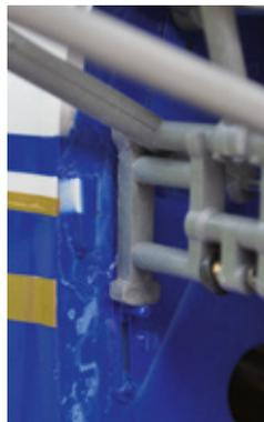
Auf dem gedämpften Stahlstift stützt sich das Fahrwerk im ausgezogenen Zustand ab. Die Klappe wird gegen den Anschlag gezogen (mit weißem Spritzschatten)
