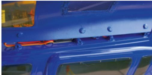
Die Domhaube wird mit drei Schrauben und acht Magneten befestigt und liegt perfekt auf, ohne Dellen zu werfen
