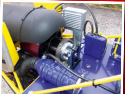
Dort, wo normalerweise eine Turbine vorgesehen ist, befindet sich ein Außenläufermotor Hacker A80. Weitere Komponenten: Controller Kontronik Kosmik 200, 12s-LiPos mit 10.000 Milliamperestunden Kapazität, Hauptrotordrehzahl 850 Umdrehungen pro Minute, Flugzeit etwa acht Minuten
