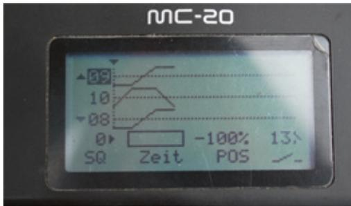
Das Menü Sequenzer der mc-20. Hier werden die Kanäle festgelegt (Kanal 9 = Hauptfahrwerk, 10 Klappen, 8 Bugfahrwerk) sowie der Schaltreihenfolge bestimmt
