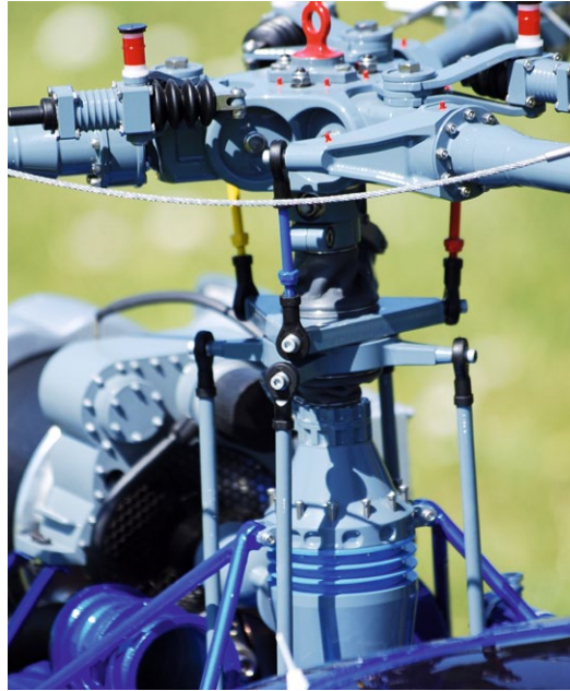
Der Dreiblatt-Hauptrotor nebst Dom, Abstreibungen und Taumelscheiben-Anlenkung ist extrem detailliert ausgeführt
