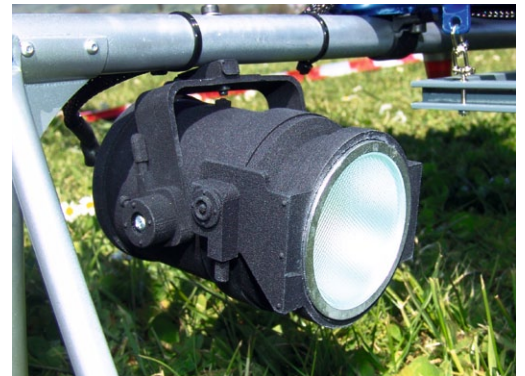
Aus dem 3D-Drucker stammt das Gehäuse des am Kufenlandegestell angebrachten Suchscheinwerfers
