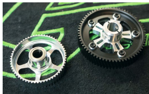
Das Hauptzahnrad ist gefräst und besitzt extrem gute Rundlaufeigenschaften
