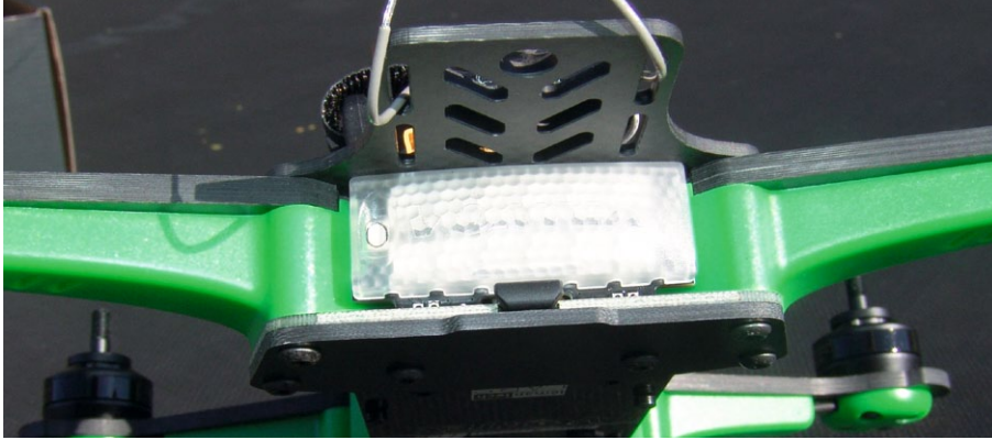
Der kleine weiße Tastschalter am LED-Board dient zum manuellen Umschalten des FPV-Frequenzbands
