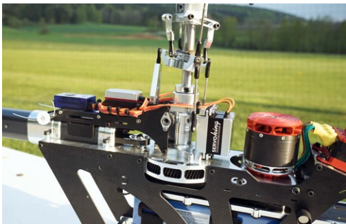
Die Seitenansicht verdeutlicht den klar strukturierten Aufbau der Kernmechanik
