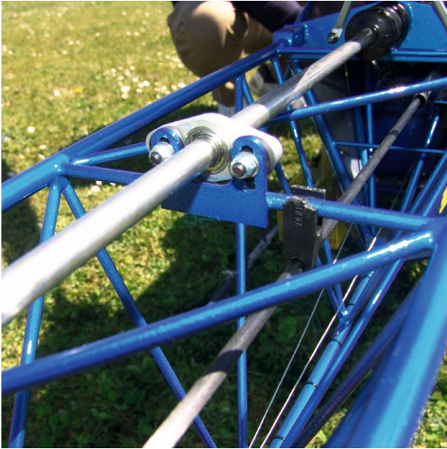
Der Antrieb des Heckrotors erfolgt über eine freiliegende Starrwelle. Gut zu erkennen auch das schwarze Schubgestänge für die Heckrotor-Anlenkung
