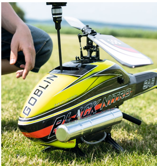
Der Sechskant-Adapter des Starters wird in die Lüfterrad-Aufnahme eingesetzt
