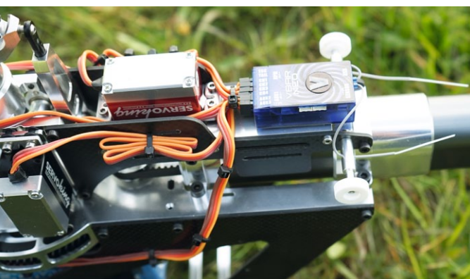
Das Heckservo (Kopfmontage) sitzt mittig im Chassis, dahinter das Mikado NEO Flybarless-System
