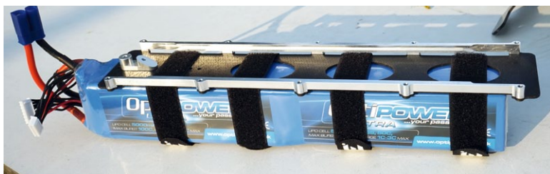
Der 12s-OptiPower-Akku „ultra“ mit einer Kapazität von 5.000 Milliamperestunden ist auf der Akkuplatte festgezurret
