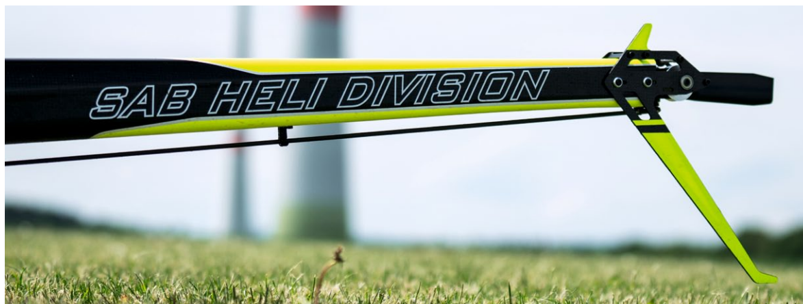
Der CFK-Heckausleger mit Carbo-Heckgestänge und Finne
