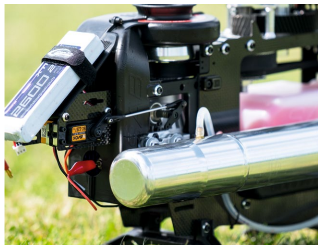
Blick auf den Hatori-Dämpfer, dahinter das Drosselgestänge nebst Servo. Der 2s-LiPo sitzt schwerpunktsgünstig ganz vorne
