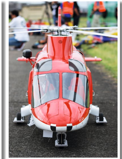
Eines der beeindruckendsten Scale-Modelle war die Agusta A109 K2 von Roland Kaufmann, deren Vierblattrotor einen Durchmesser von 3,3 Meter hat. Angetrieben wird dieses Großmodell, das aus einem Bausatz von Hermann Auer stammt, von einer JetCat SPT5H Zweiwellenturbine. Das Abfluggewicht beträgt knapp 30 Kilogramm
