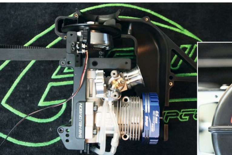
Modular: Die mit Zahnriemen versehene Nitro-Einheit
