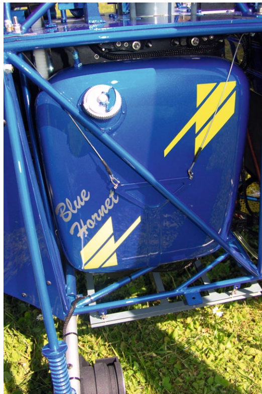
Der Tank mit Scale-Metall-Verschluss und Seil-Verzurrung
