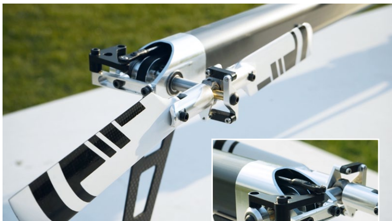
Und so sieht die fertig montierte Heckrotor-Einheit mit ihrem obenliegenden Umlenkhebel und montierter Pitchbrücke aus
