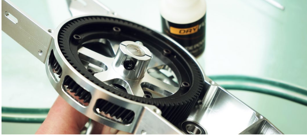
Ansicht von unten: Das mit der 12er-Rotorwelle verbundene, im Core-Zentralteil sitzende Hauptzahnrad
