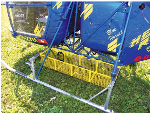
Der auch beim bemannten Vorbild eingesetzte Lastenkorb darf beim Modell nicht fehlen
