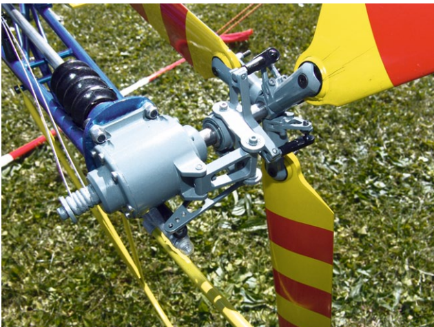
Steuerseil-Attrappen der Heckrotor-Anlenkung
