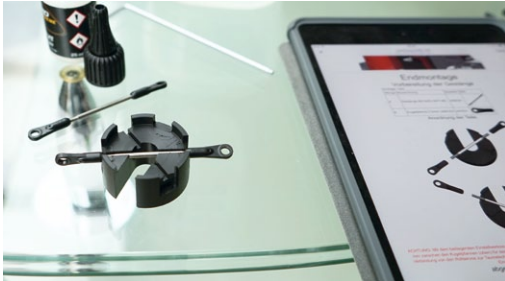
Mitgedacht: Perfektes Einstellwerkzeug für Gestänge und die Taumelscheibe
