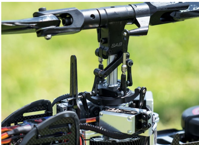
Mattschwarz präsentiert sich der auf der 12er-Welle sitzende Hauptrotor mit seiner Anlenkung
