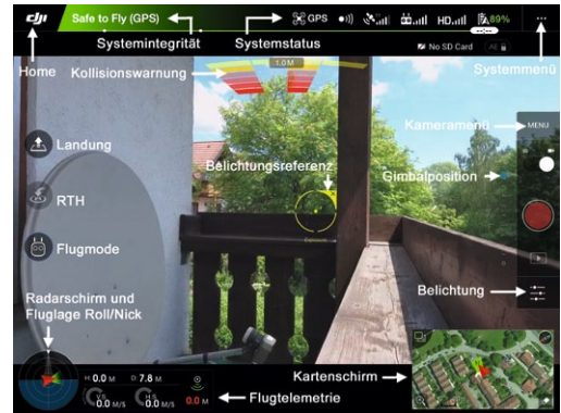
Typischer Flugbildschirm. Kollisionswarnung links entspricht der Wand, rechts dem Balken. Alle Piktogramme der oberen Zeile sind Buttons für weitere Infos
