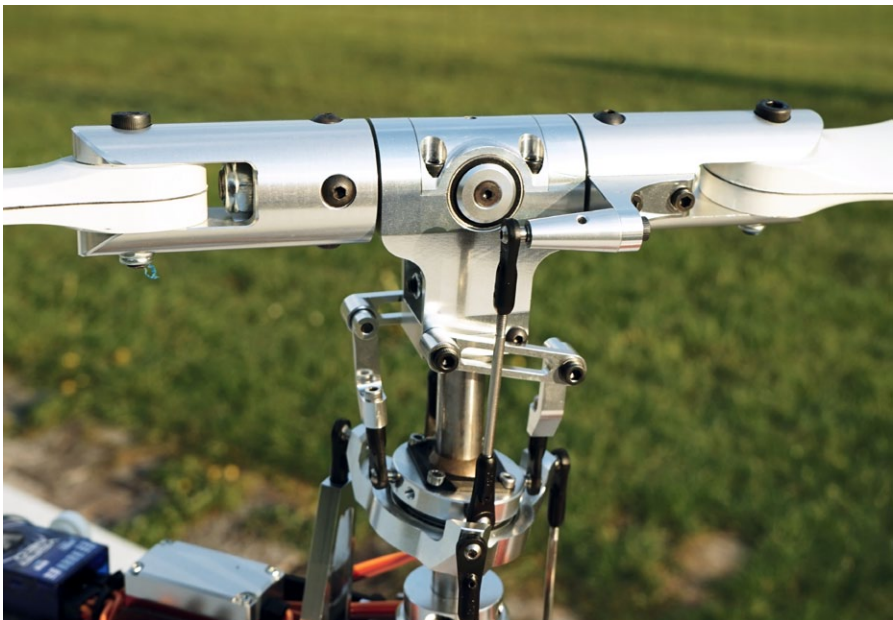
Der CORE 700 bringt ein neuartiges Rotorkopf-Konzept mit sich, bei dem neben der besonderen Dämpfung auch eine 12er-Rotorwelle und eine 10er-Blattlagerwelle mit M8-Außengewinden eingesetzt werden. Die Taumelscheibe ist mit einem leichtgängigen Schwenklager und Messingkugel versehen, die Anlenkung erfolgt klassisch über 120 Grad
