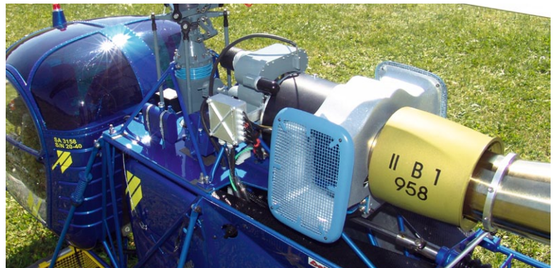
Turbomeca-Look: Die zum Einsatz kommende Jakadofsky-Turbine Pro 5000 wurde mit entsprechenden Anbauteilen optisch ans Vorbild angepasst
