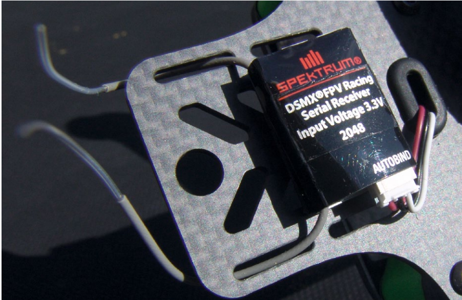
Der serienmäßig verbaute Spektrum SPM4648 DSMX bietet eine Auto-Bind-Funktion und Summsignal
